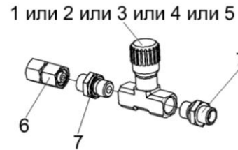
Рисунок 163 – Дроссель регулируемый КВК 0602340
