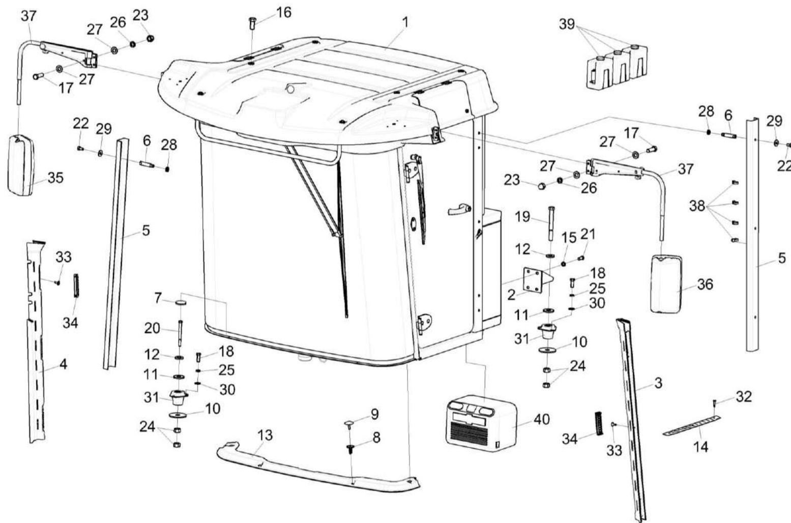
Рисунок 157 – Установка кабины КВК-650-10-0120000
