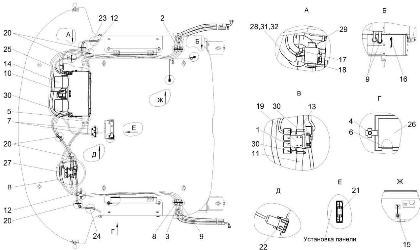
Рисунок 190 – Установка испарителя КВК-650-11-0121020
