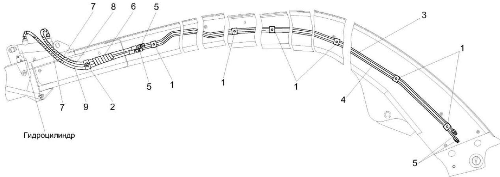
Рисунок 237 – Гидросистема силосопровода КВК-650-10-0602090
