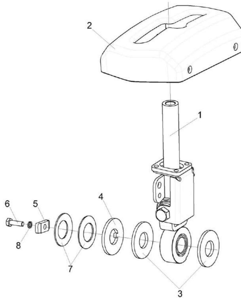
Рисунок 176 – Установка привода ГСТ УКК-01-0205810
