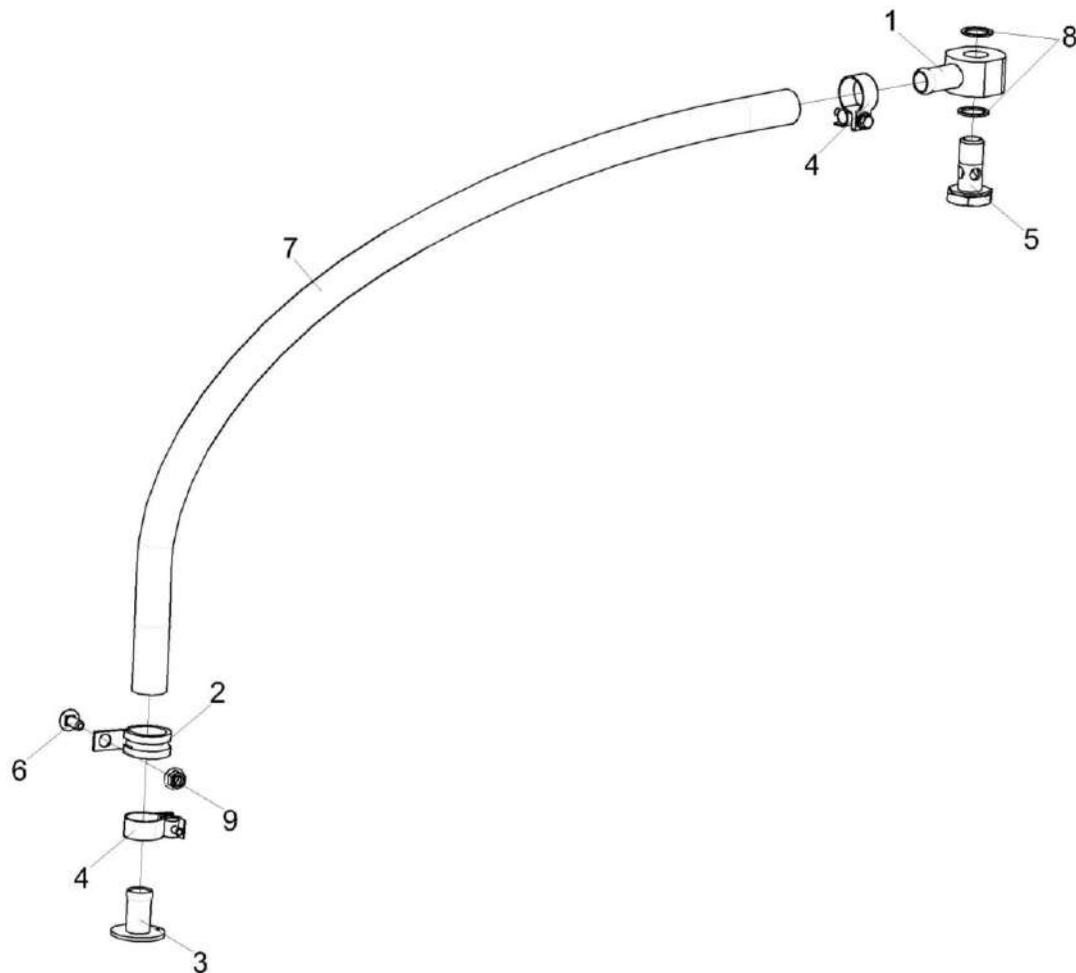
Рисунок 96 – Установка сливного рукава КВК-650-11-0150180
