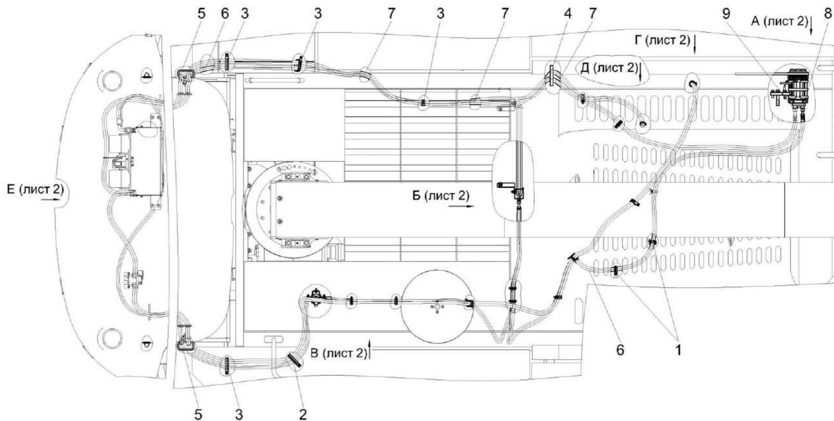
Рисунок 183 – Установка оборудования кондиционера КВК-650-11-0121010 (лист 1)
