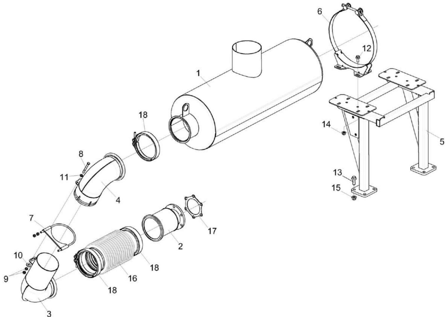
Рисунок 100 – Установка глушителя КВК-650-11-0157000
