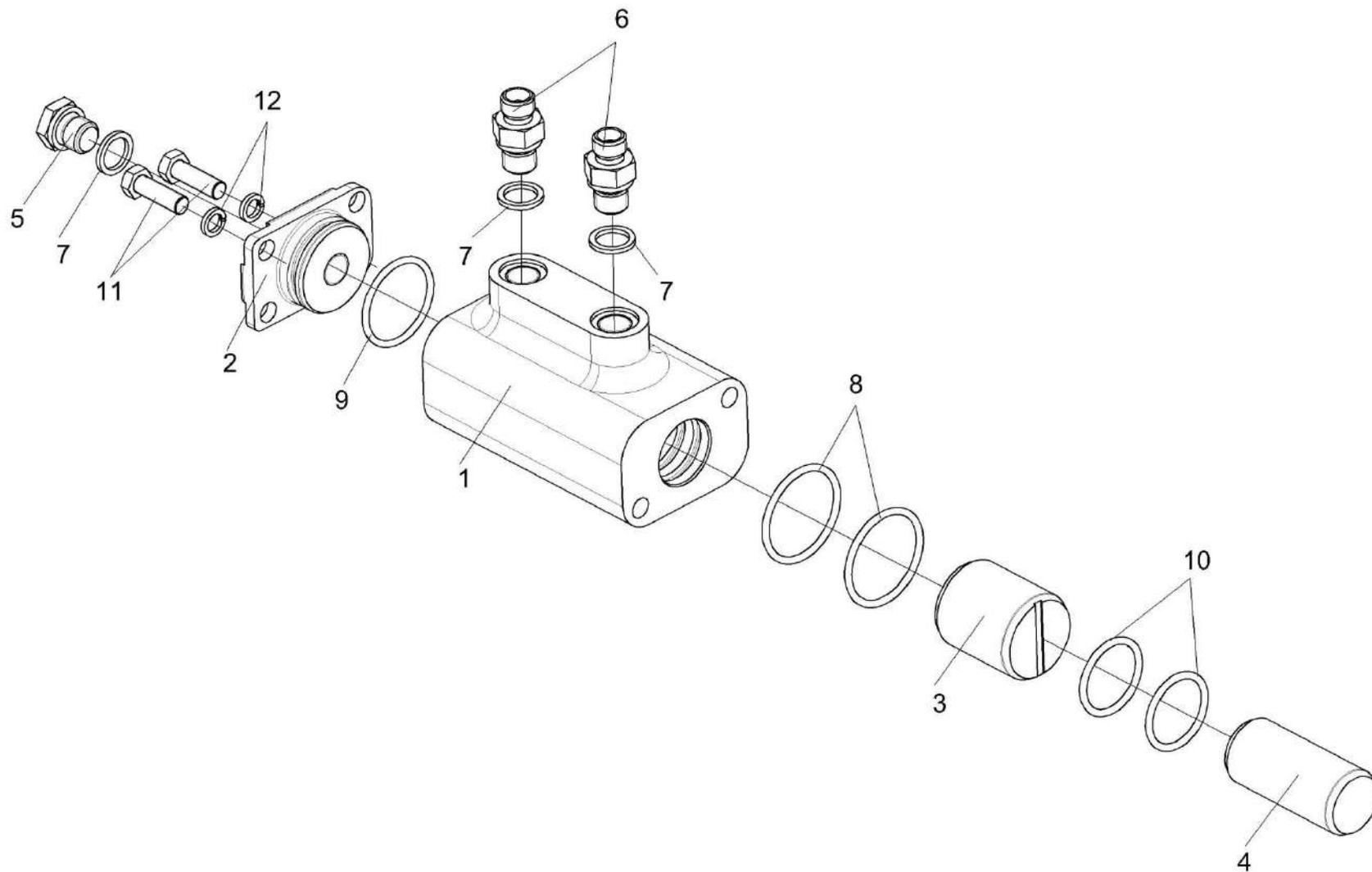
Рисунок 124 – Гидроцилиндр УЭС-16-5131010
