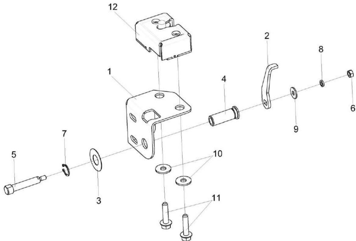
Рисунок 142 – Замок КВК-650-10-0160450 и КВК-650-10-0160450-01 (зеркальное отражение)
