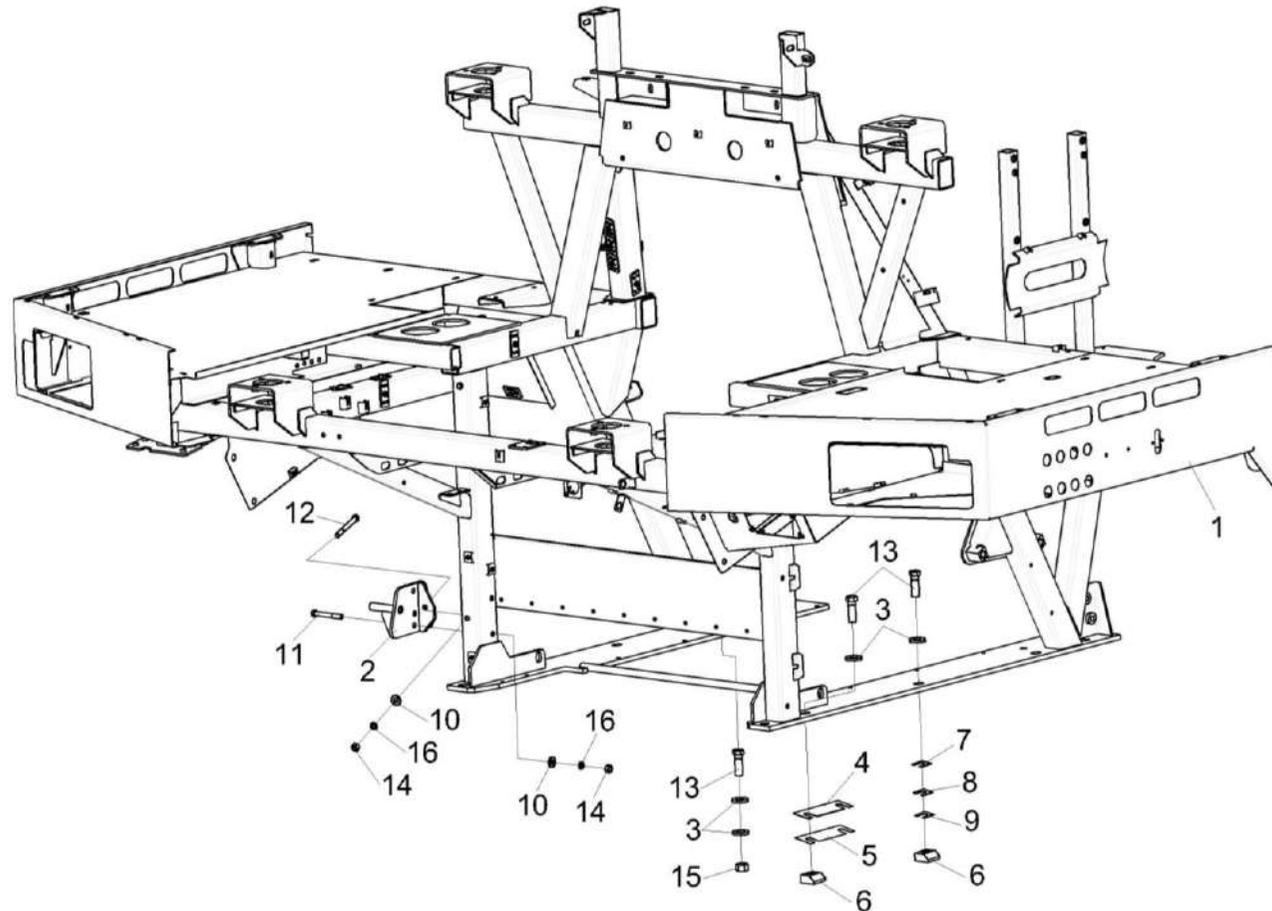
Рисунок 145 – Установка площадки входа КВК-650-10-0124000
