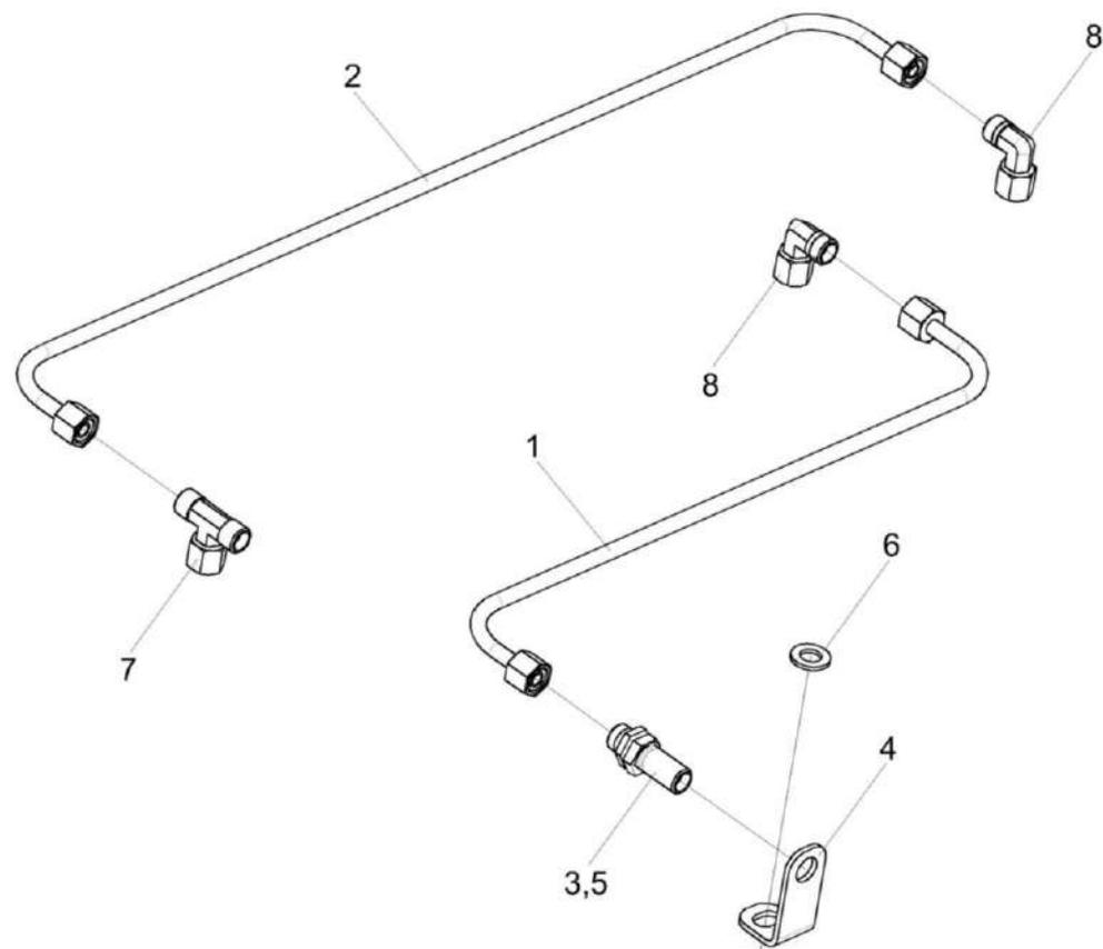
Рисунок 230 – Установка трубопроводов КВК-650-10-0601900
