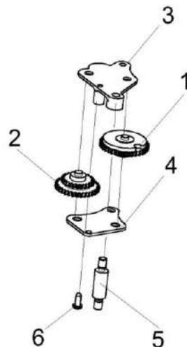
Рисунок 171 – Привод КЗК-13-0119300
