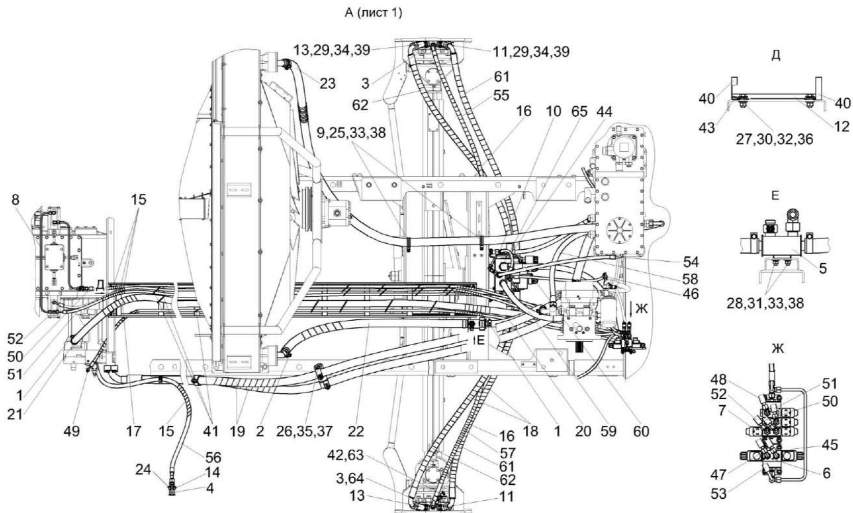
Рисунок 225 – Гидросистема привода ходовой части КВК-650-11-0601000 (лист 2)
