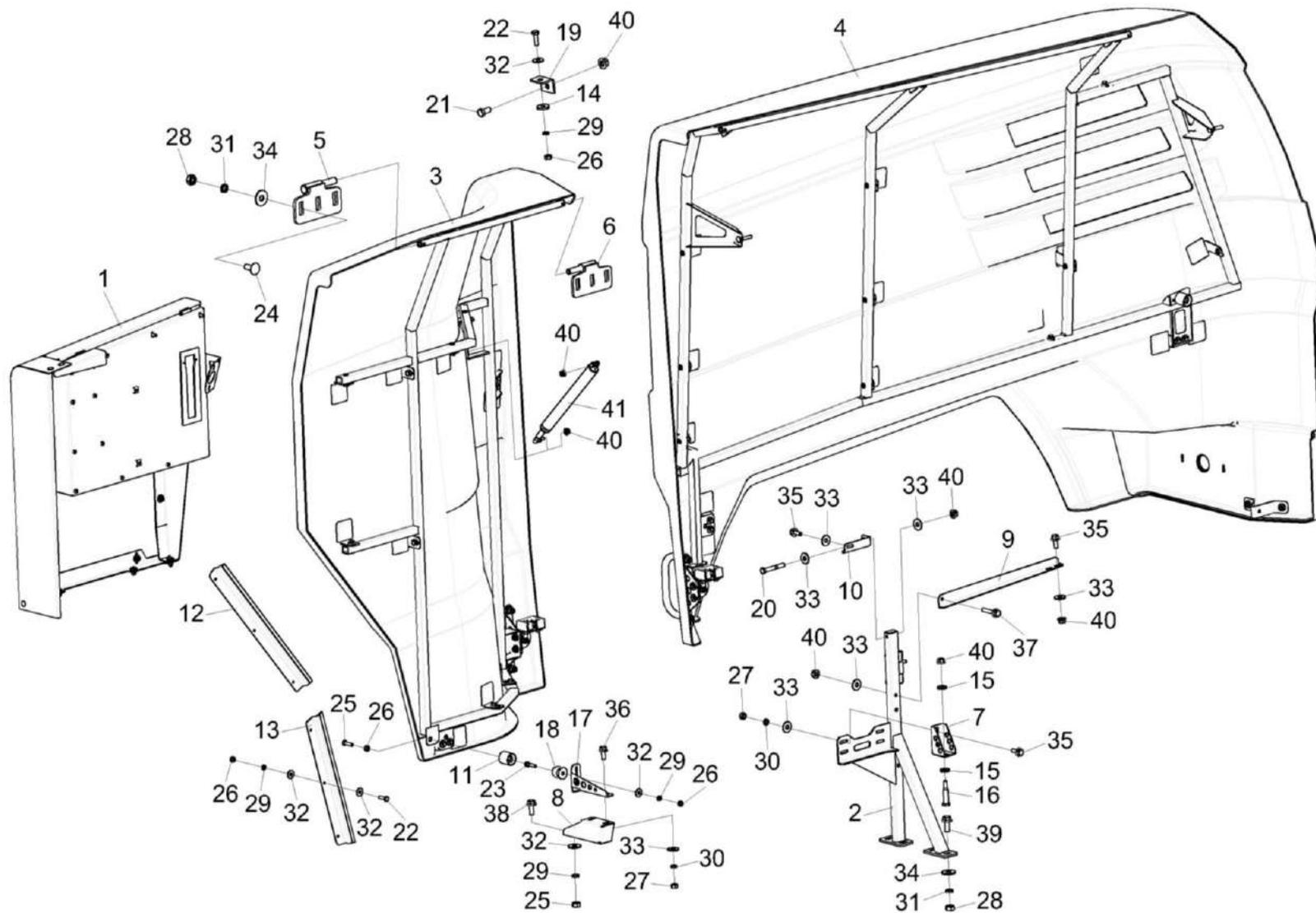
Рисунок 134 – Установка капотов КВК-650-10-0160000 (лист 2)
