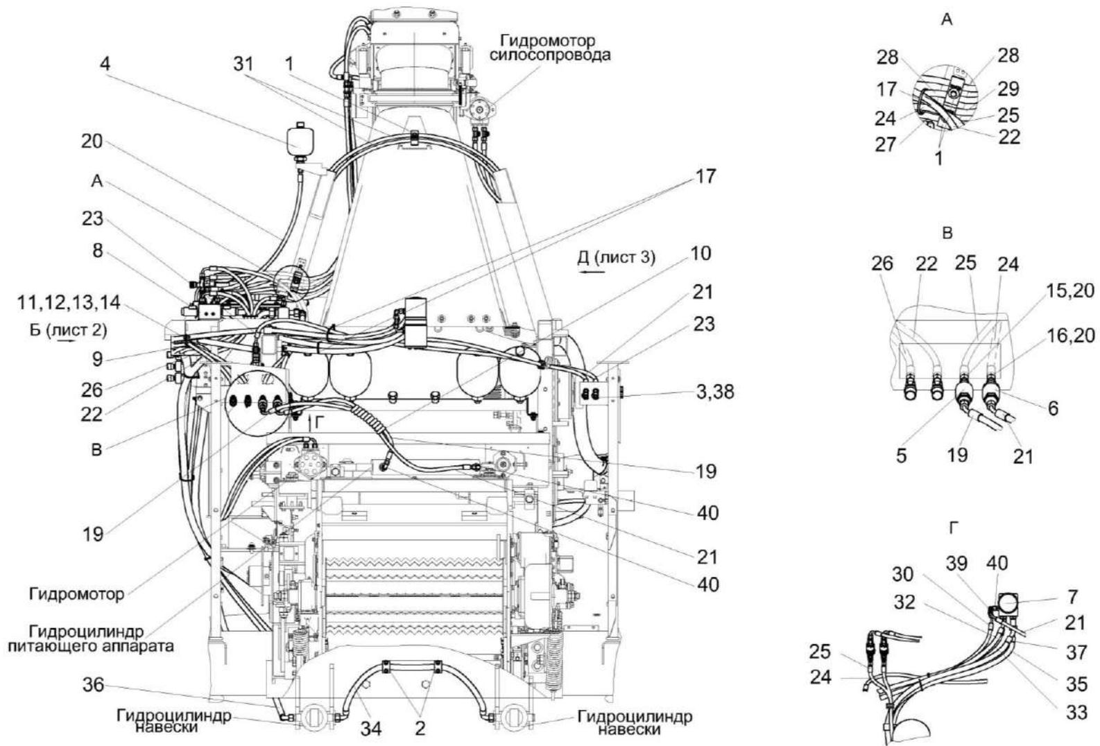
Рисунок 231 – Гидросистема рулевого управления и силовых гидроцилиндров КВК-650-11-0602000 (лист 1)
