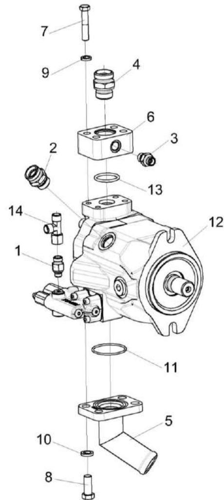
Рисунок 221 – Гидронасос КВК-650-10-0602100
