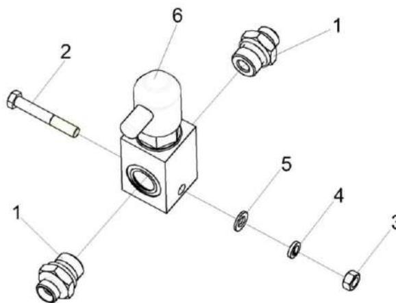
Рисунок 203 – Переключатель манометрический КВК-650-10-0801080
