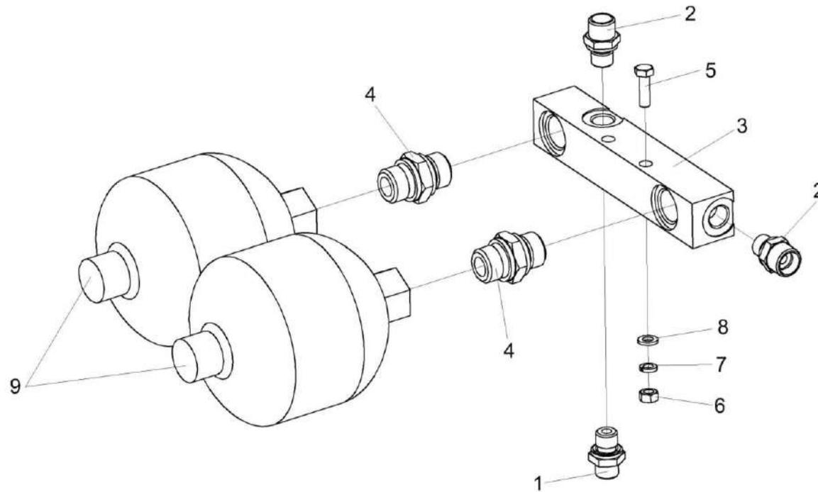
Рисунок 247 – Блок пневмогидроаккумуляторов КВК-6-0606370
