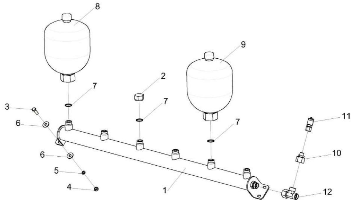
Рисунок 240 – Блок пневмогидроаккумуляторов КВК-650-10-0602340
