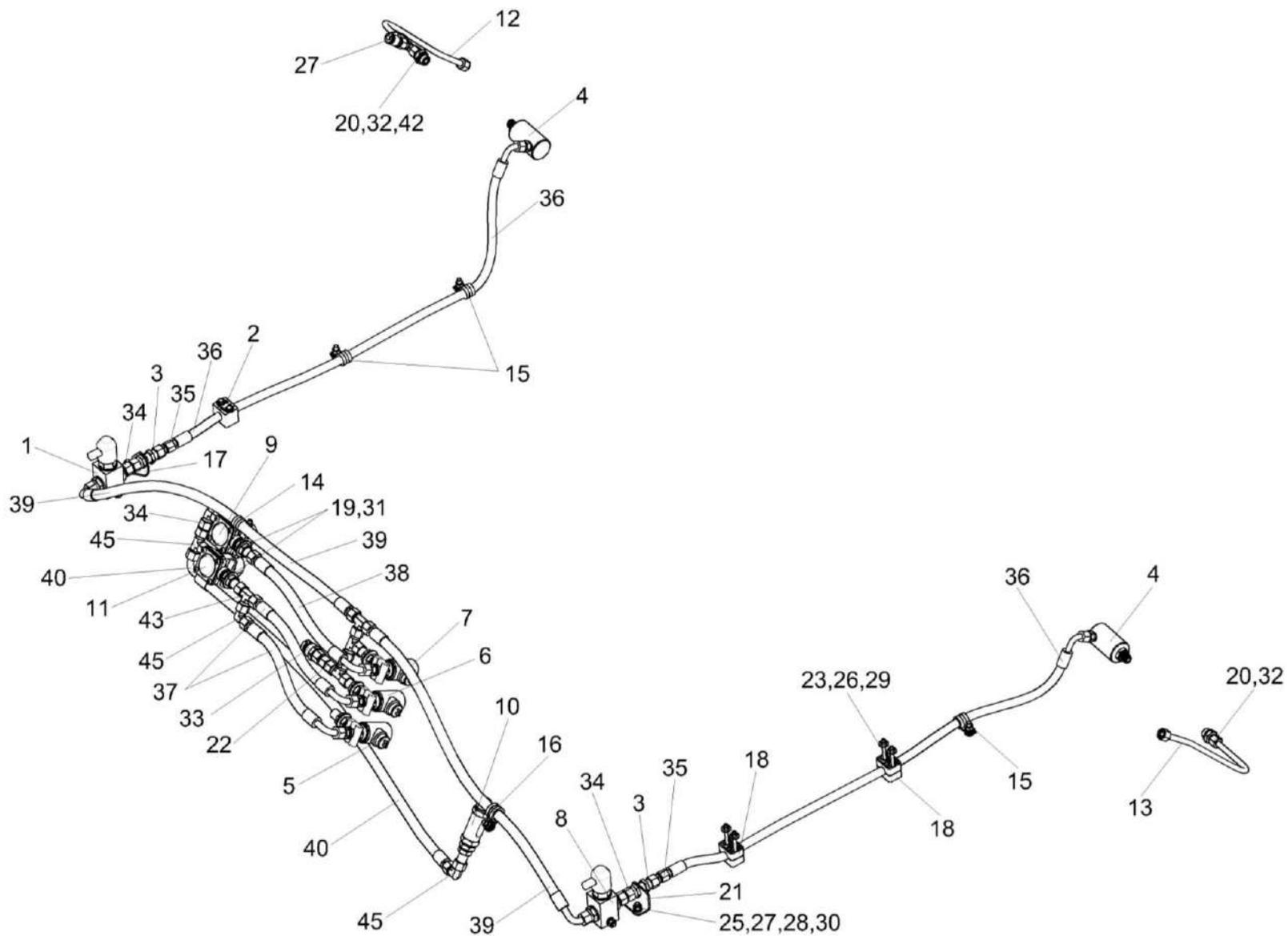
Рисунок 202 – Пневмосистема подкачки шин КВК-650-10-0801000
