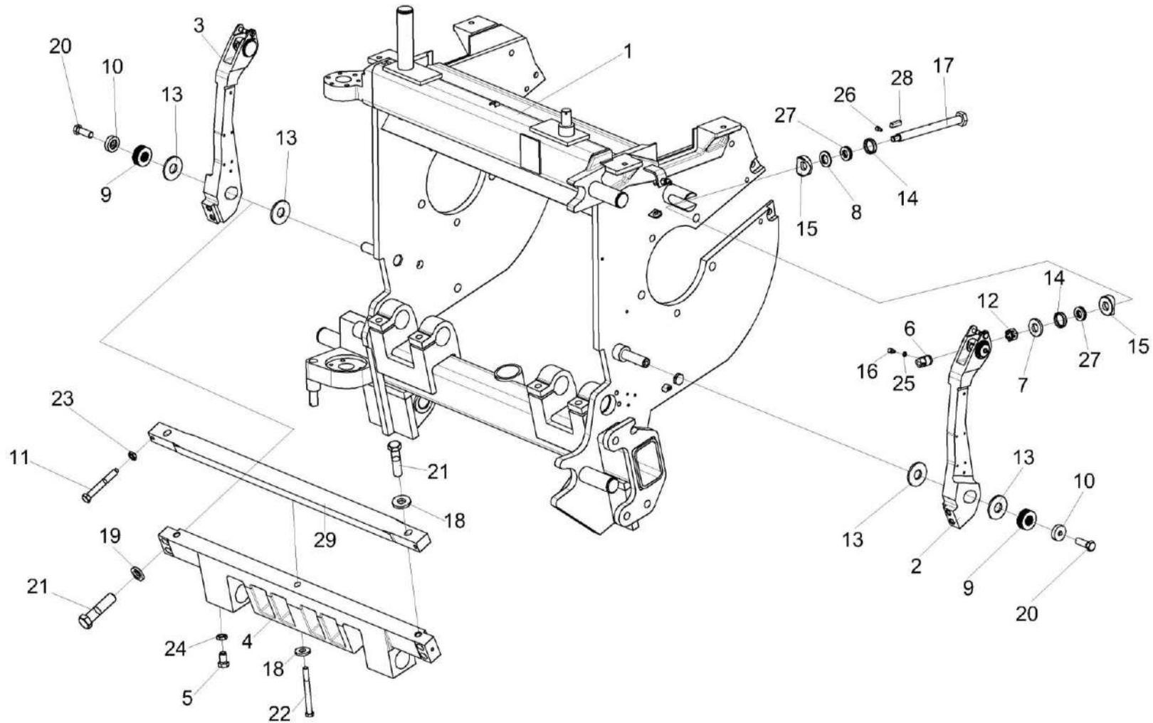
Рисунок 34 – Установка рычага КВК 0115170А и КВК 0115170А-01
