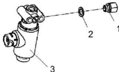
Рисунок 200 – Клапан электромагнитный КВК-650-10-0800200
