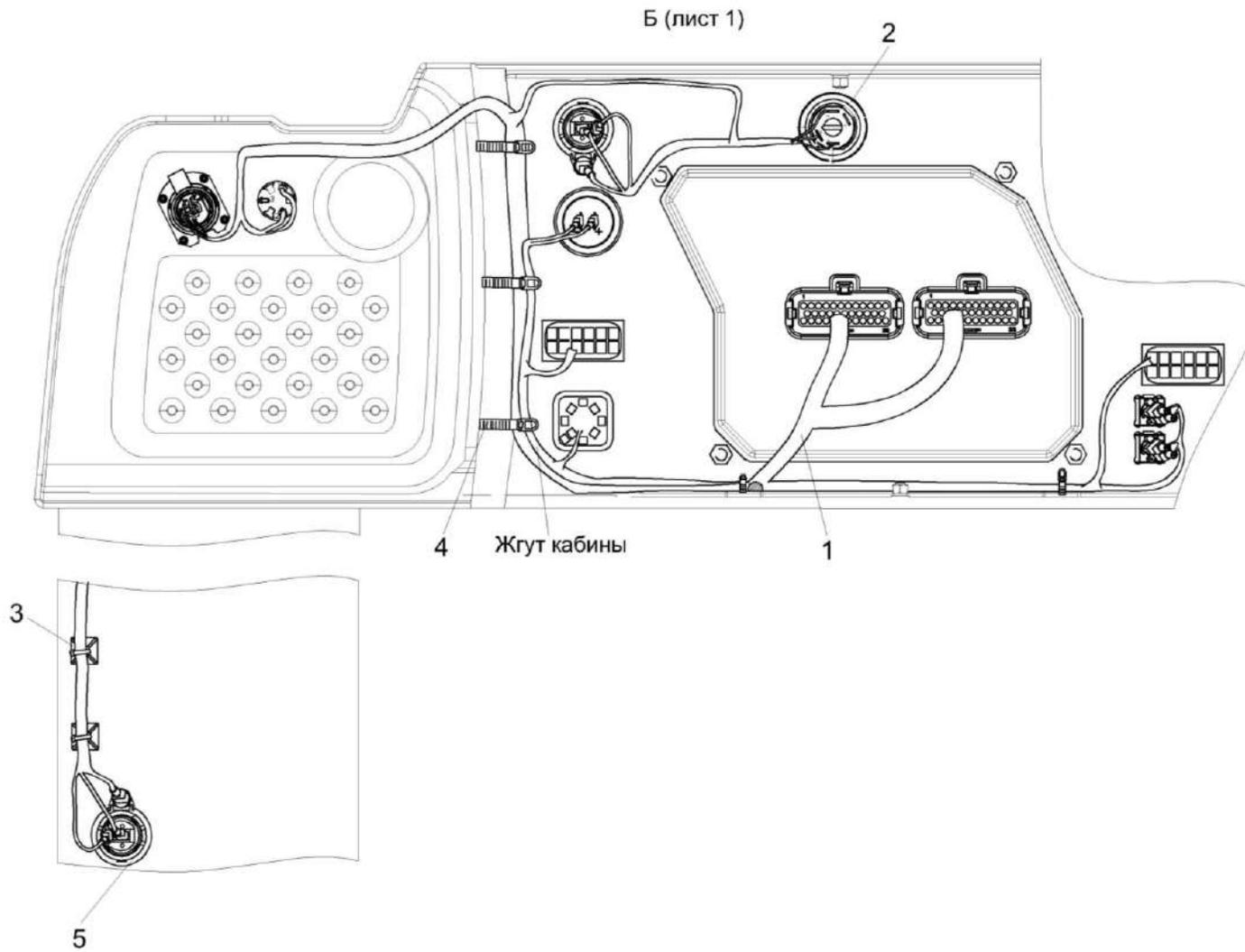
Рисунок 264 – Установка электрооборудования пульта управления КВК-650-11-0725000 (лист 3)
