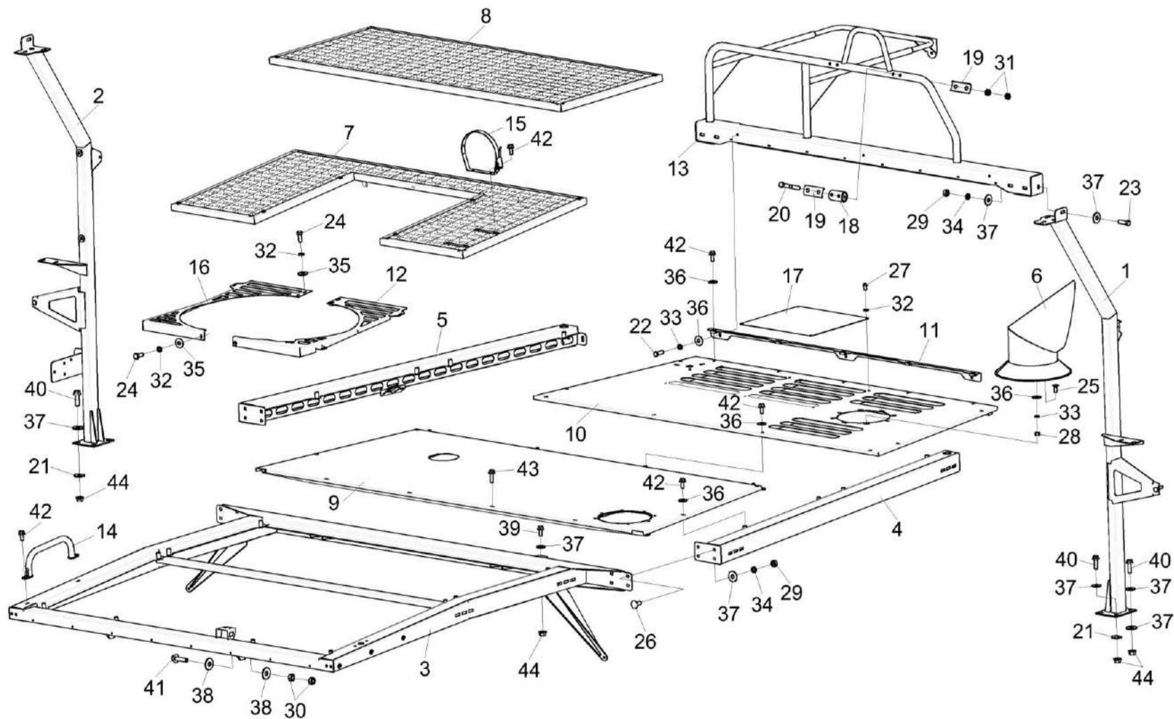
Рисунок 144 – Крыша КВК-650-10-0162000
