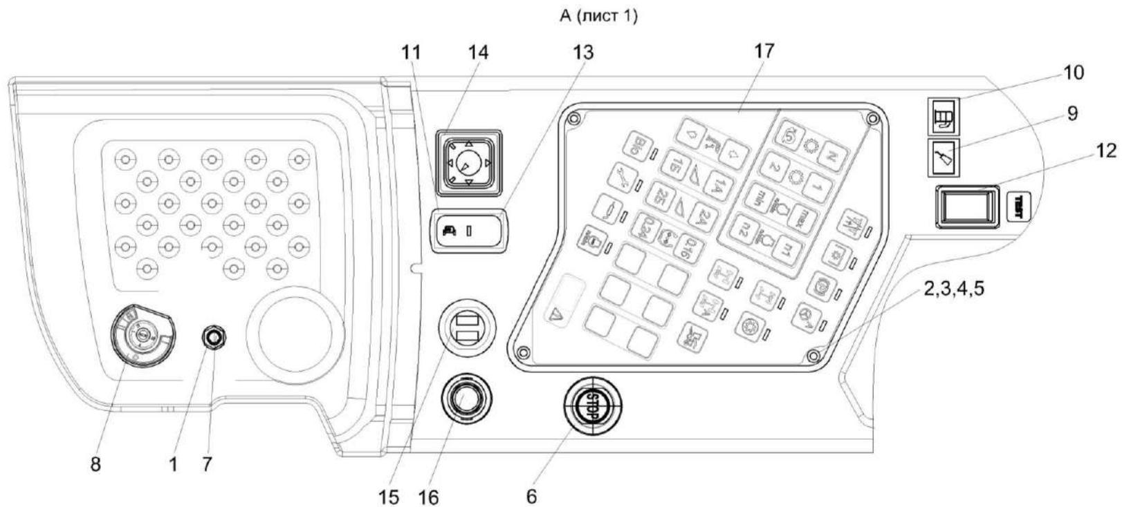
Рисунок 263 – Установка электрооборудования пульта управления КВК-650-11-0725000 (лист 2)
