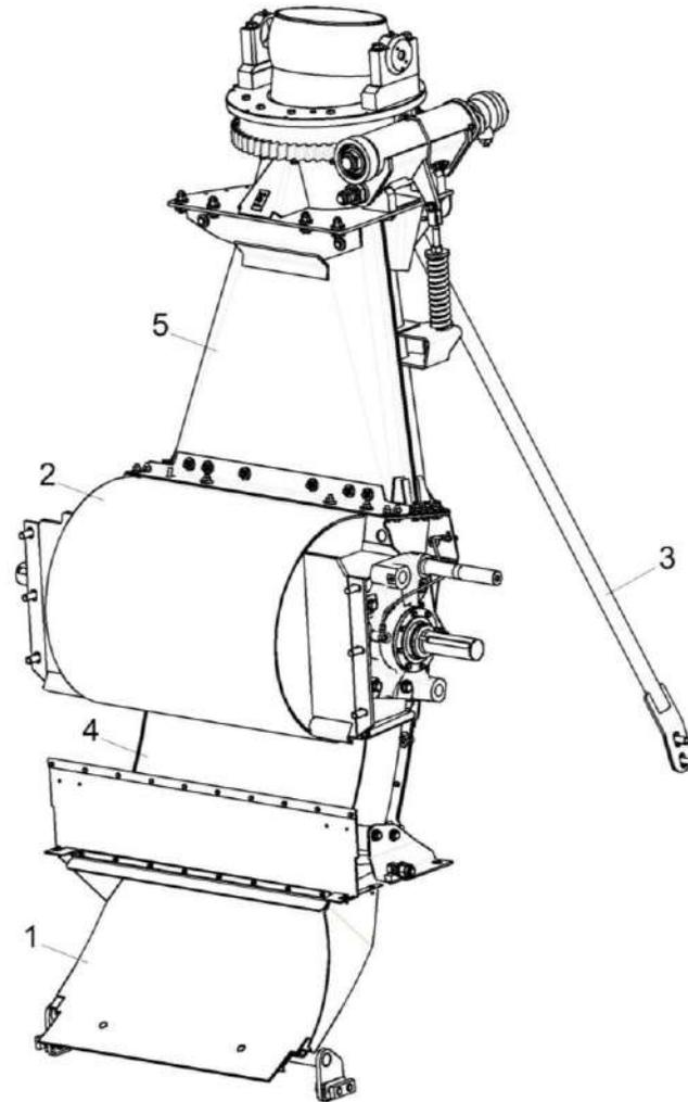
Рисунок 55 – Установка технологического тракта КВК-650-10-0140000 (общий вид)
