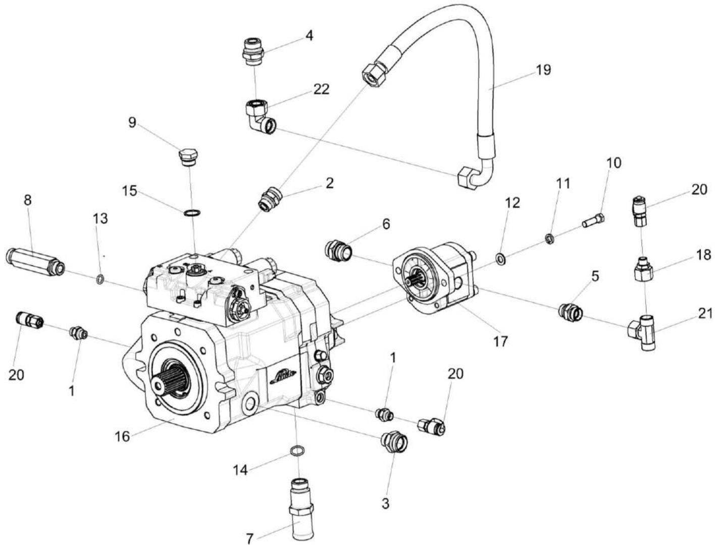
Рисунок 223 – Гидронасос двухсекционный КВК-650-10-0604120
