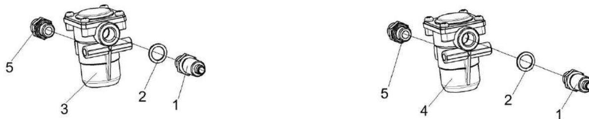
Рисунок 207 – Клапан давления КВК-2-0801090 и КВК-6-0801090
