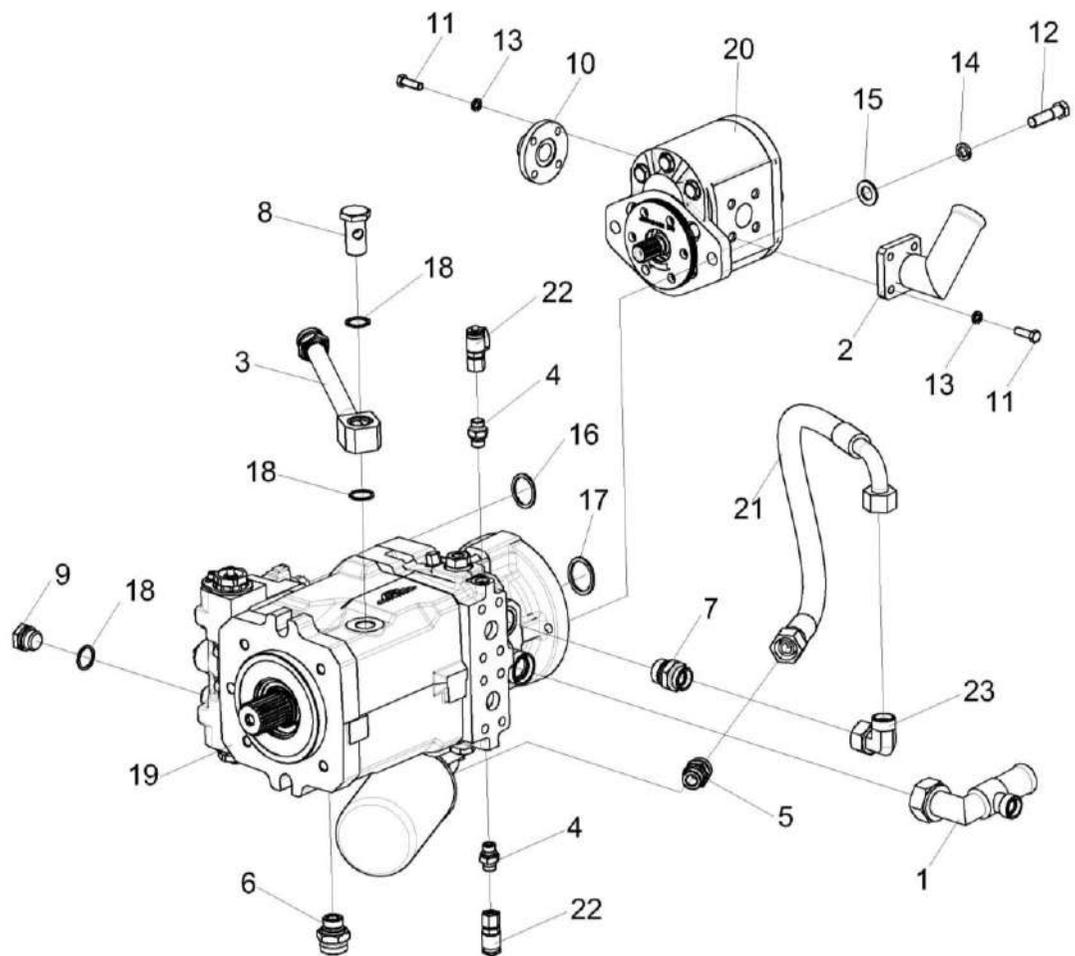
Рисунок 222 – Гидронасос двухсекционный КВК-650-10-0604110
