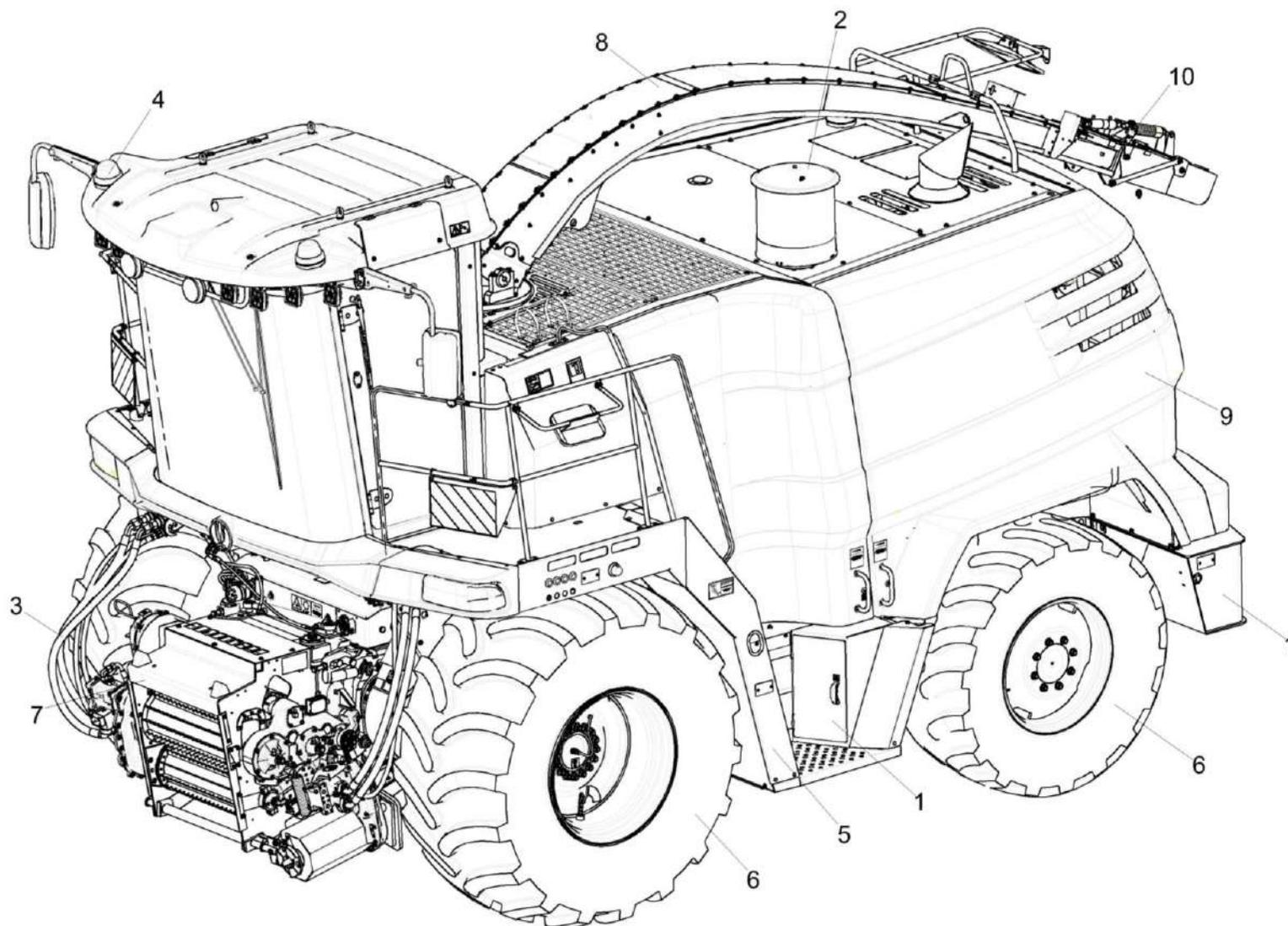
Рисунок 1 – Комбайн кормоуборочный самоходный FS650 КВК-650-11-0100000 (общий вид)
