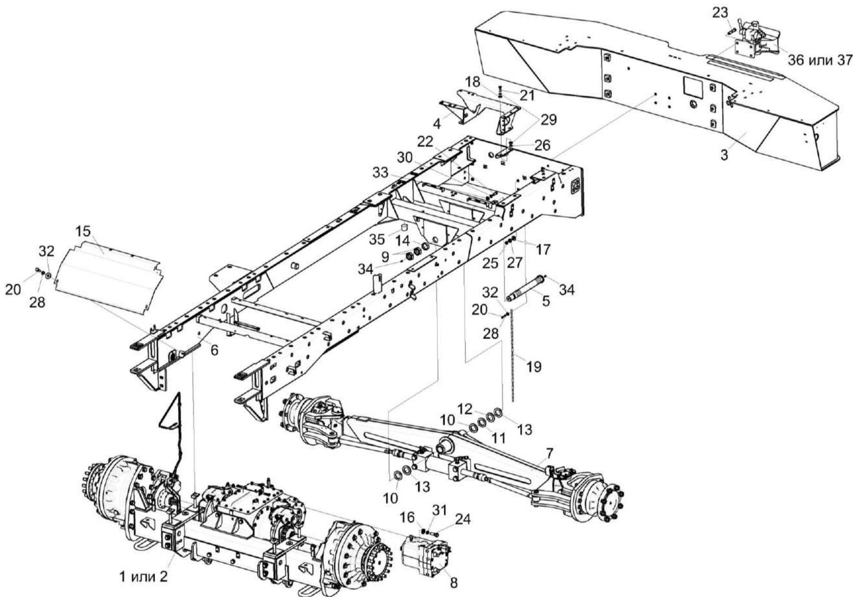
Рисунок 108 – Шасси КВК-650-11-0101000
