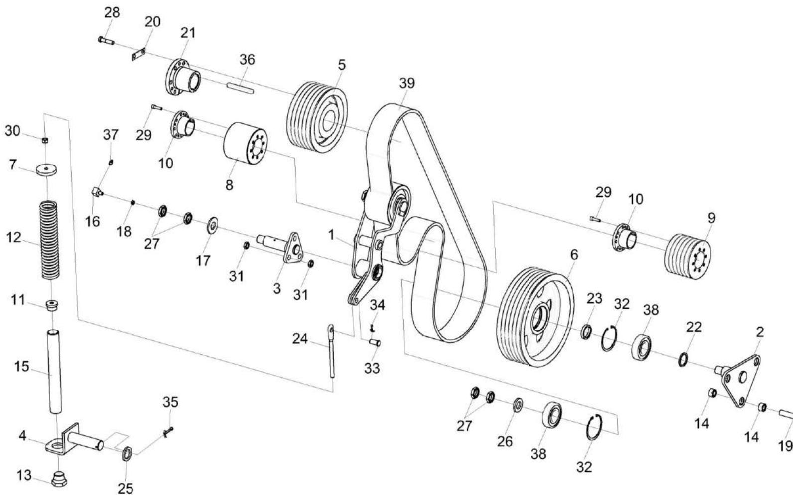
Рисунок 46 – Привод доизмельчающего устройства КВК 0131000
