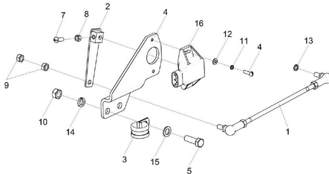
Рисунок 69 – Установка датчика КВК 0144250
