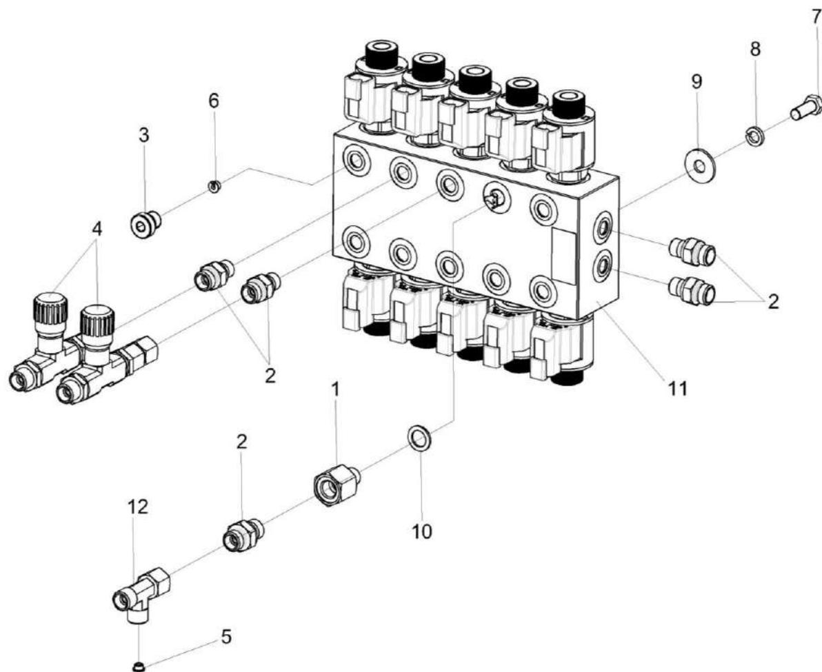
Рисунок 239 – Гидроблок пятисекционный КВК-650-10-0602330
