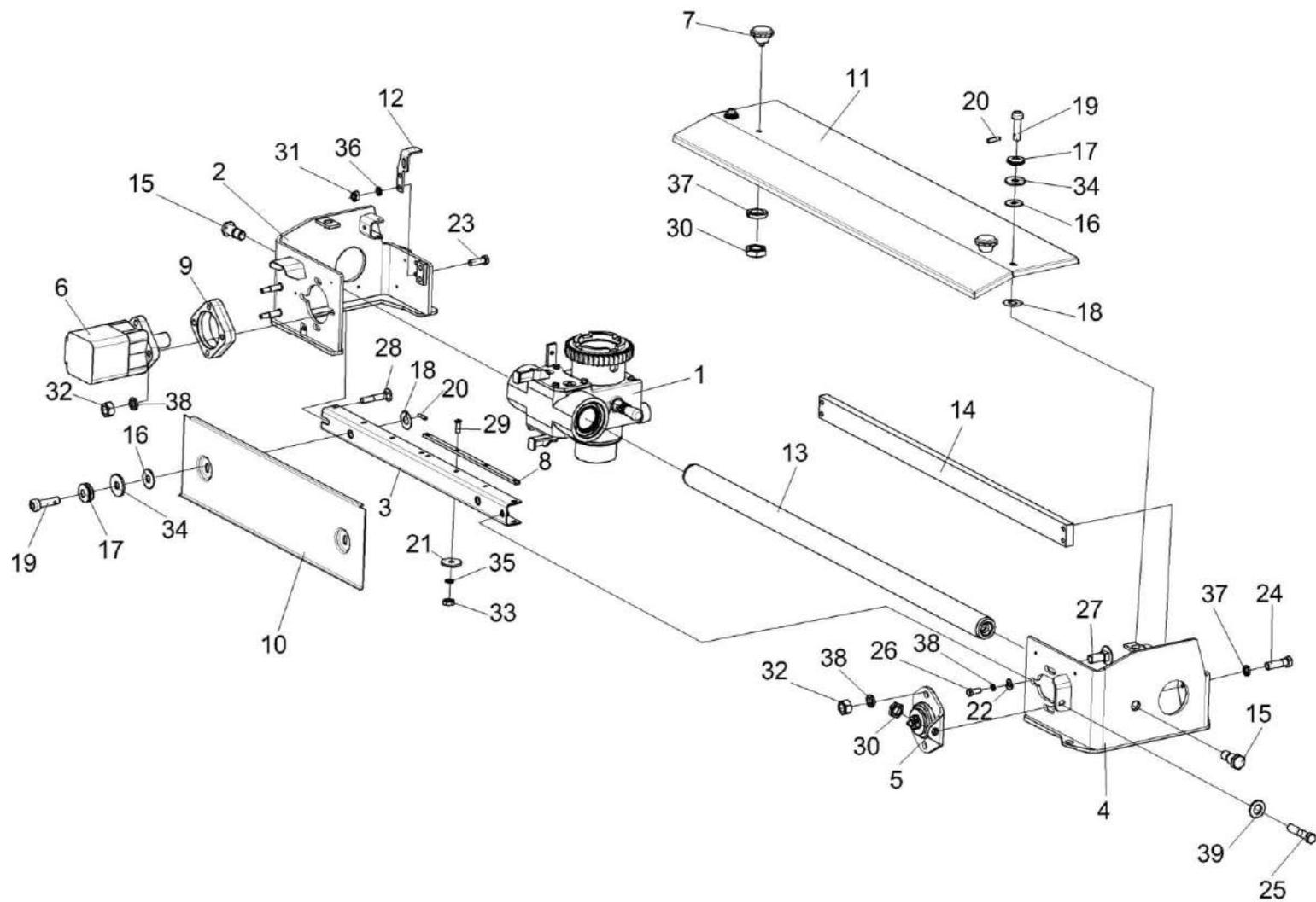
Рисунок 8 – Устройство заточное КВК-650-10-0116000
