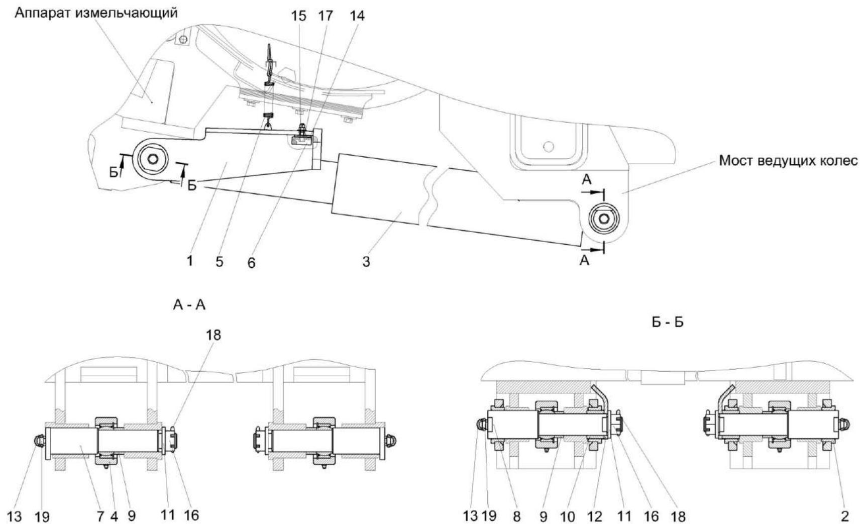
Рисунок 211 – Механизм вывешивания КВК 0105000
