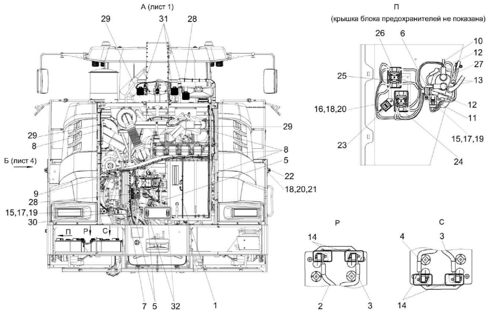
Рисунок 257 – Установка электрооборудования комбайна КВК-650-11-0721000 (лист 3)
