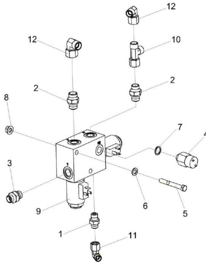
Рисунок 245 – Гидроблок стояночного тормоза КВК-650-10-0606310
