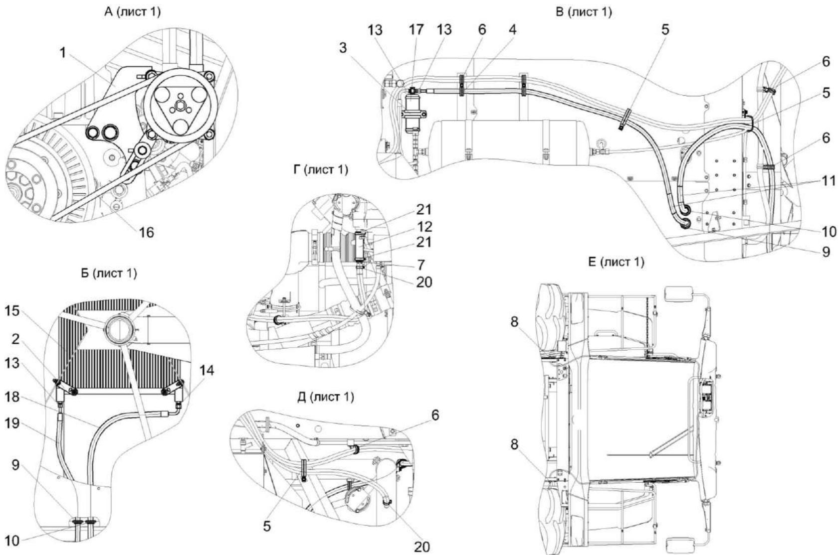
Рисунок 184 – Установка оборудования кондиционера КВК-650-11-0121010 (лист 2)
