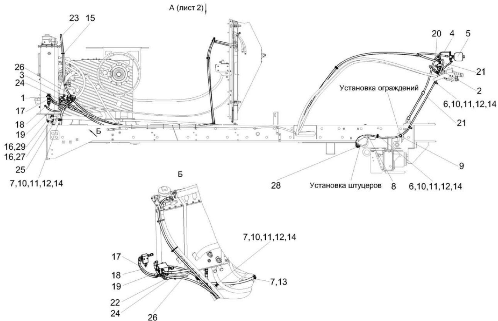
Рисунок 241 – Гидросистема привода стояночного тормоза и пылесъемника КВК-650-11-0606000 (лист 1)
