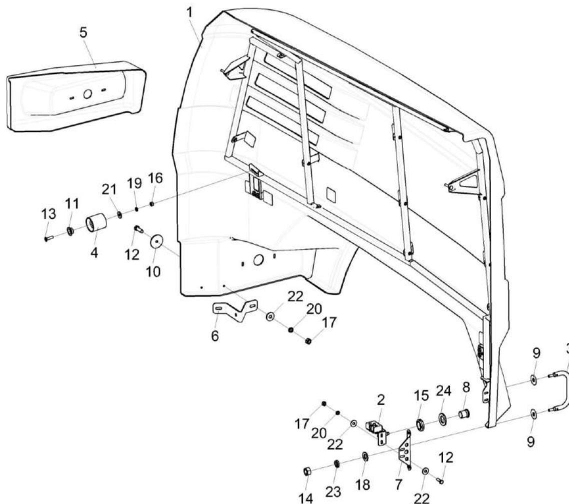
Рисунок 140 – Капот КВК-650-10-0160200 и КВК-650-10-0160200-01 (зеркальное отражение)
