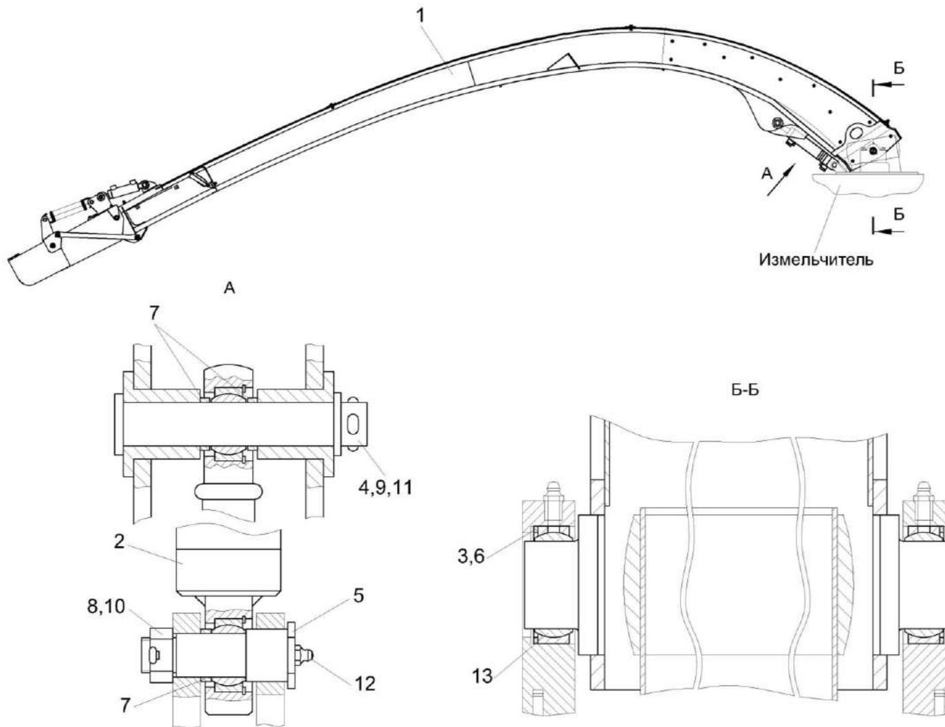
Рисунок 67 – Установка силосопровода КВК-650-10-0144000
