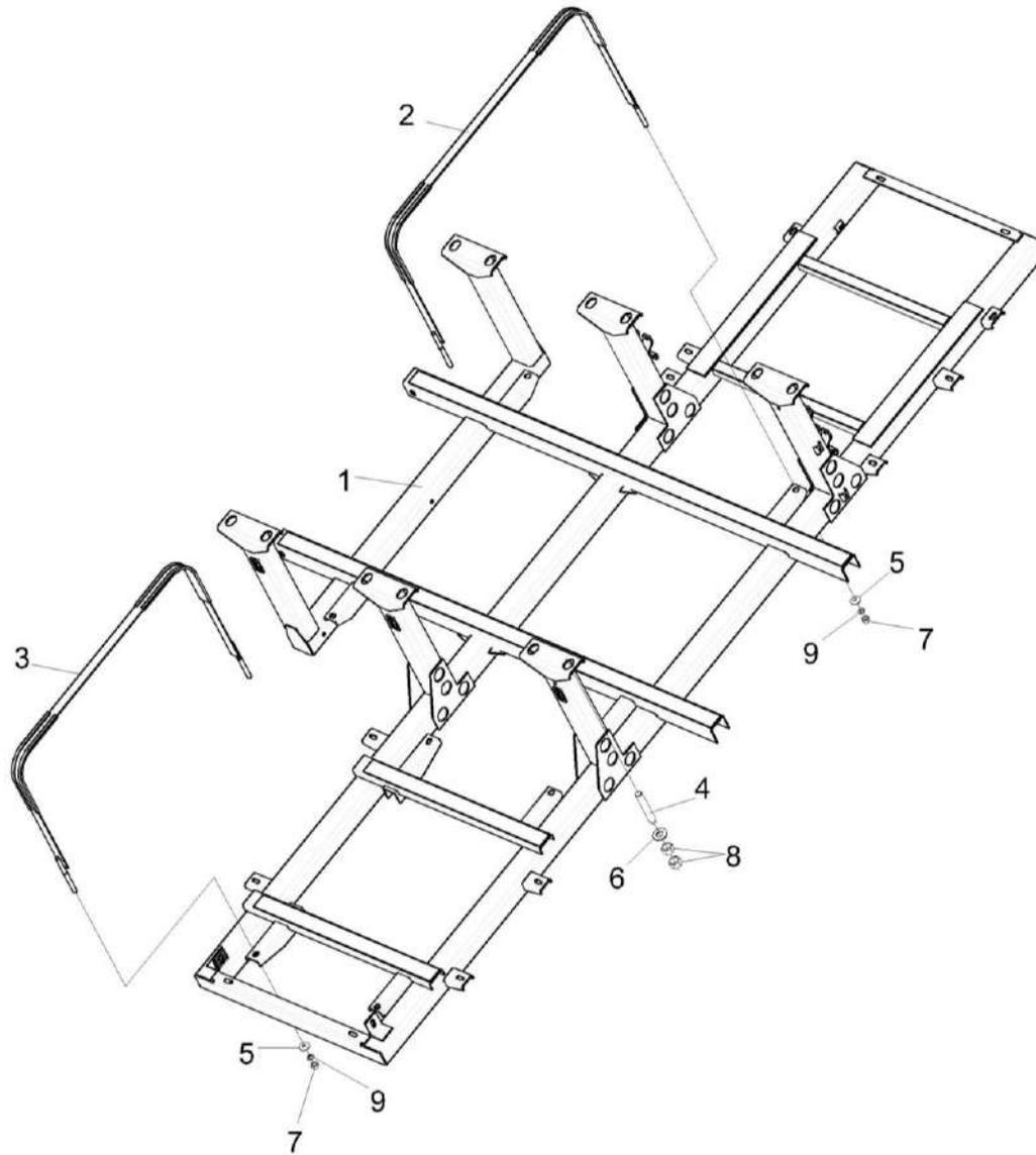
Рисунок 103 – Установка топливного оборудования КВК-650-11-0103000 (Лист 2)
