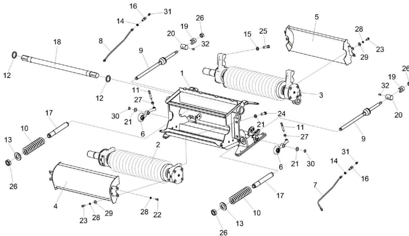
Рисунок 49 – Устройство доизмельчающее КВК 0149610 (лист 1)
