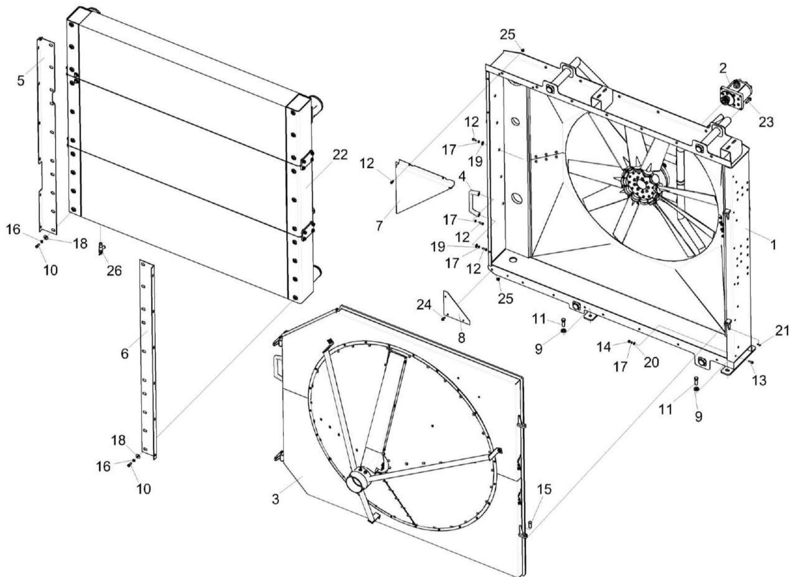
Рисунок 86 – Установка блока радиаторов КВК-650-10-0152000
