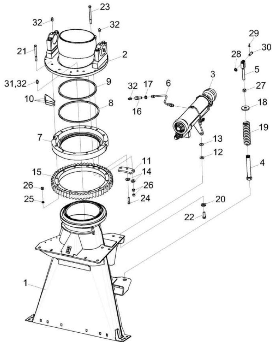
Рисунок 65 – Основание силосопровода КВК 0143000
