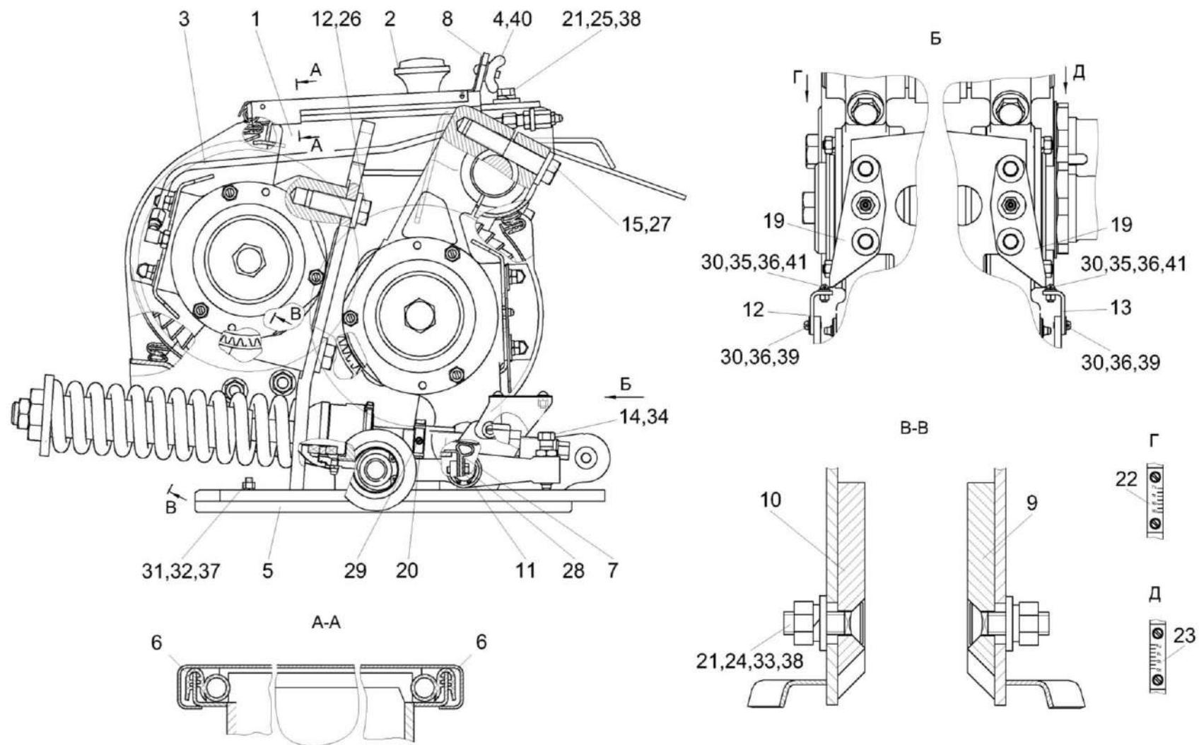
Рисунок 50 – Устройство доизмельчающее КВК 0149610 (лист 2)
