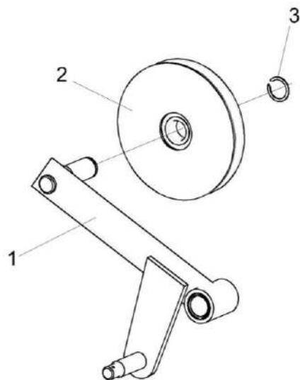
Рисунок 76 - Рычаг КВК-650-10-0150550
