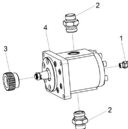
Рисунок 92 – Гидромотор КВК-650-10-0152050
