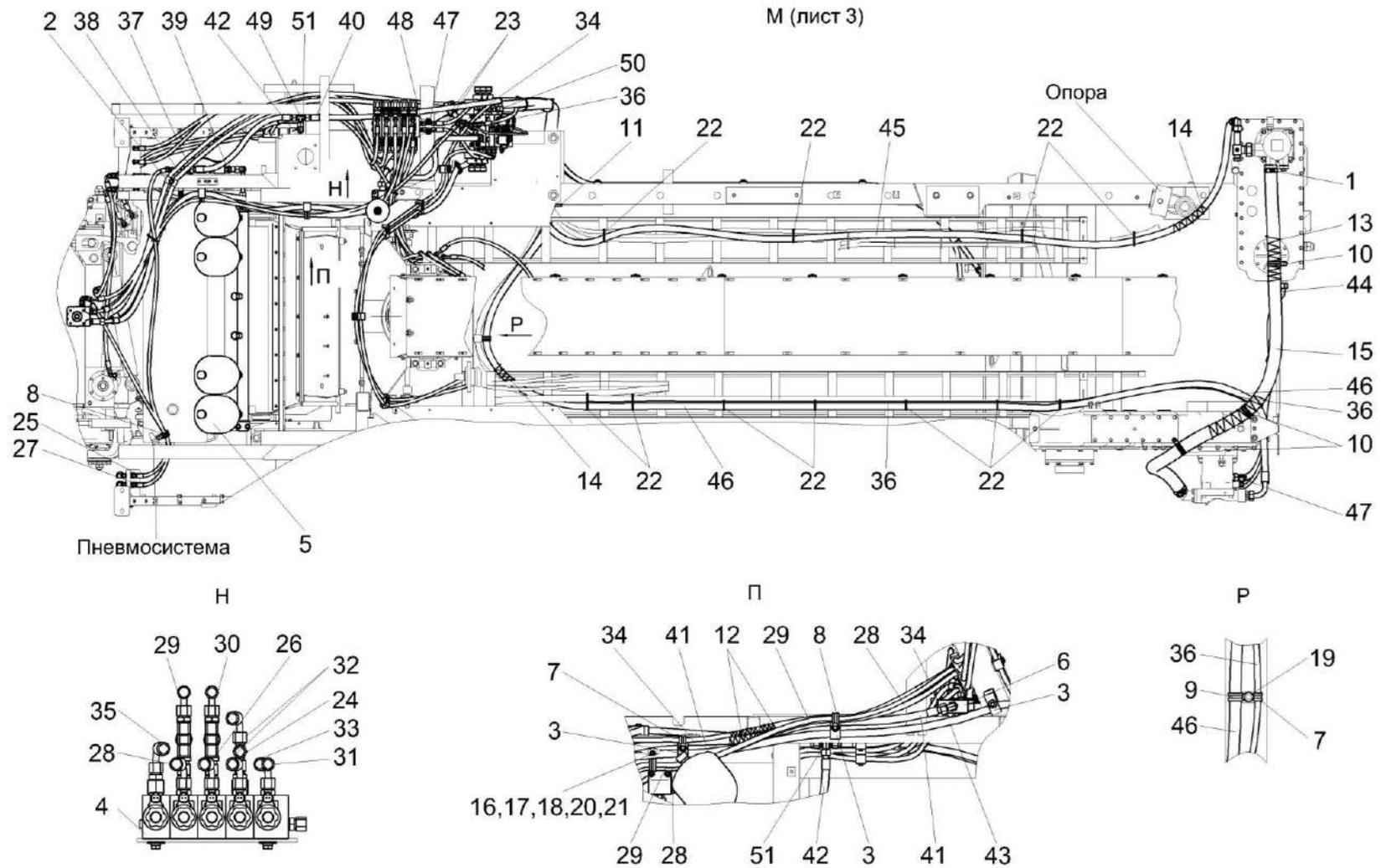
Рисунок 234 – Гидросистема рулевого управления и силовых гидроцилиндров КВК-650-11-0602000 (лист 4)
