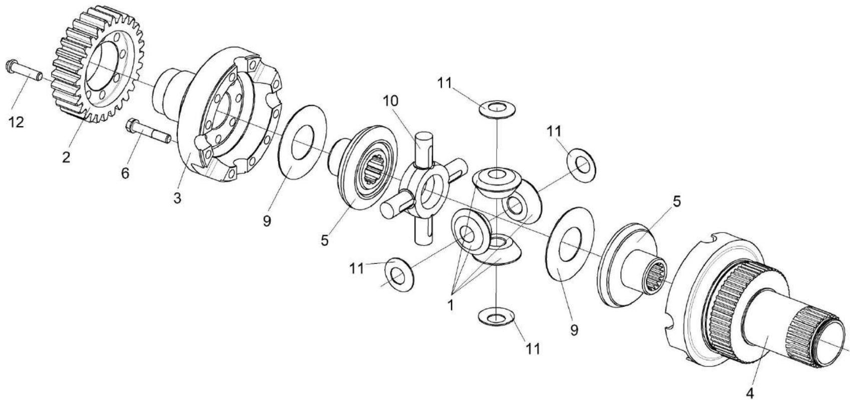
Рисунок 123 – Блок дифференциала КВК 0106200
