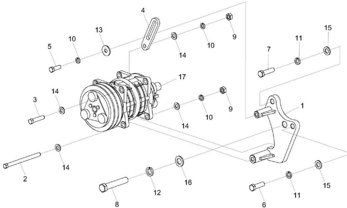
Рисунок 185 – Установка компрессора КВК-650-11-0121030
