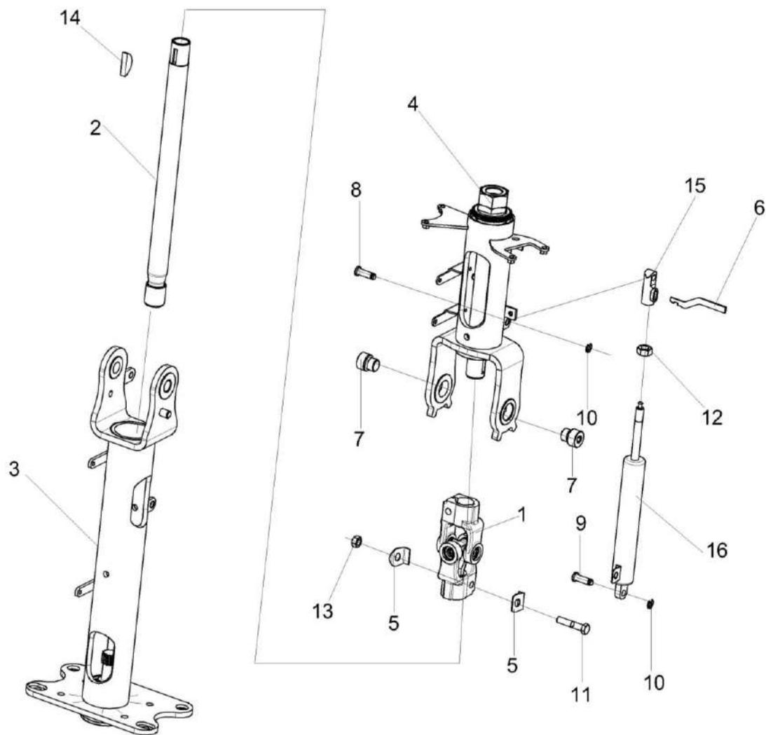
Рисунок 168 – Каркас КЗК-13-0119240
