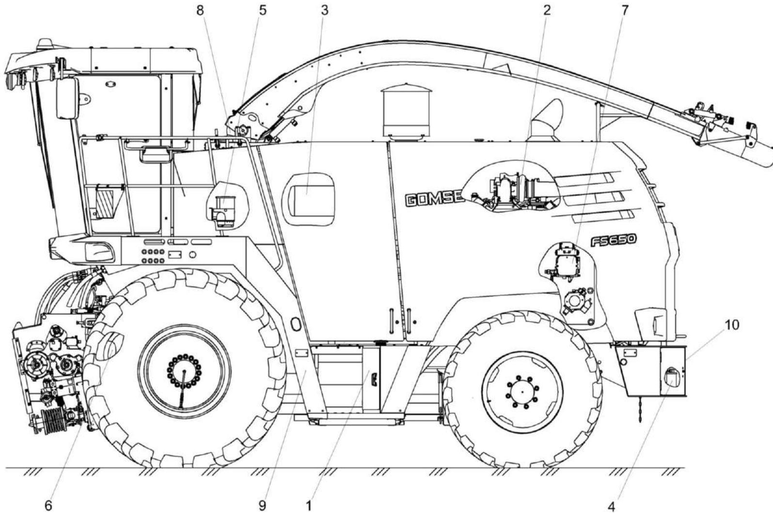
Рисунок 2 – Комбайн кормоуборочный самоходный FS650 КВК-650-11-0100000 (вид слева)
