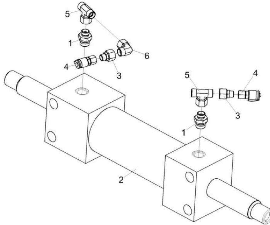
Рисунок 131 – Гидроцилиндр рулевого управления КВК-650-10-0602500
