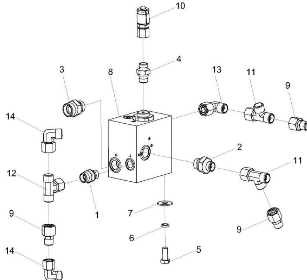
Рисунок 246 – Клапан зарядки пневмогидроаккумулятора КВК-650-10-0606380
