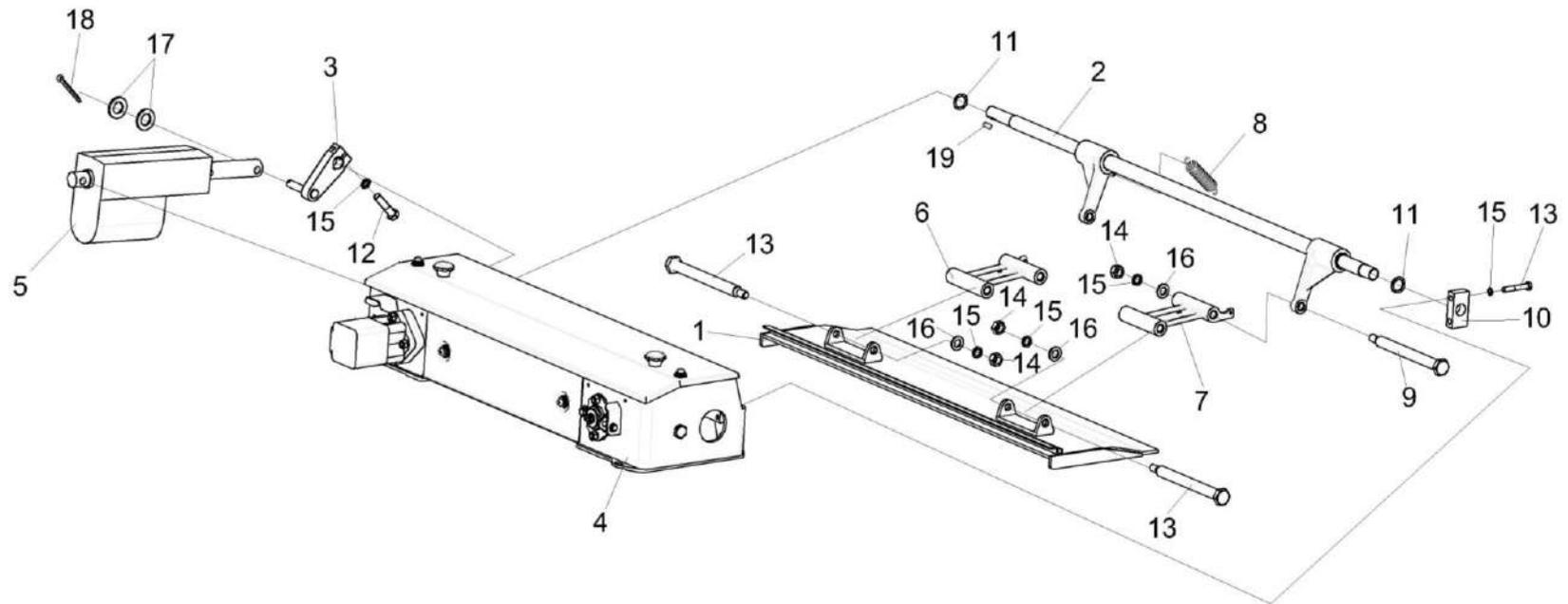
Рисунок 7 – Установка устройства заточного КВК-650-10-0116000
