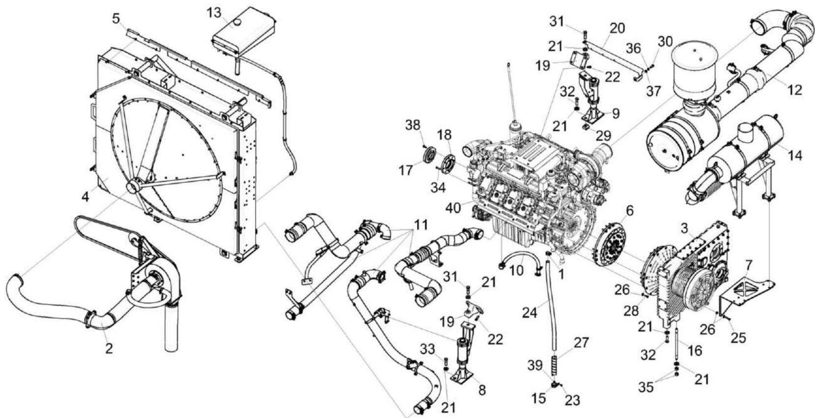
Рисунок 73 - Установка двигателя КВК-650-11-0150000
