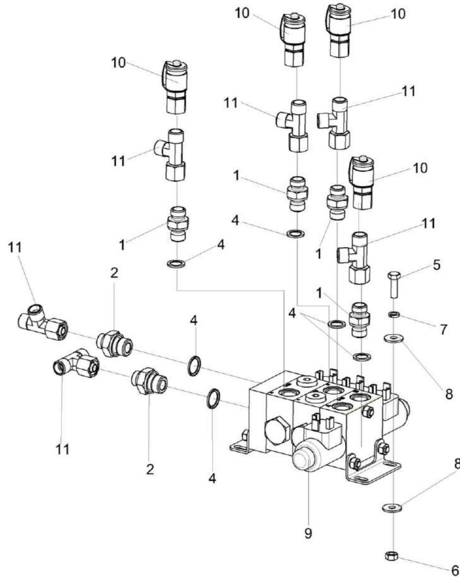
Рисунок 229 – Гидроблок управления переключением передач КВК-650-10-0601300
