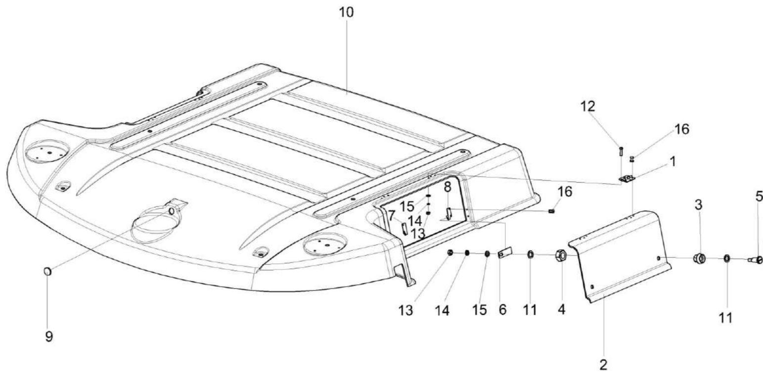
Рисунок 179 – Крыша УКК-01-0101040
