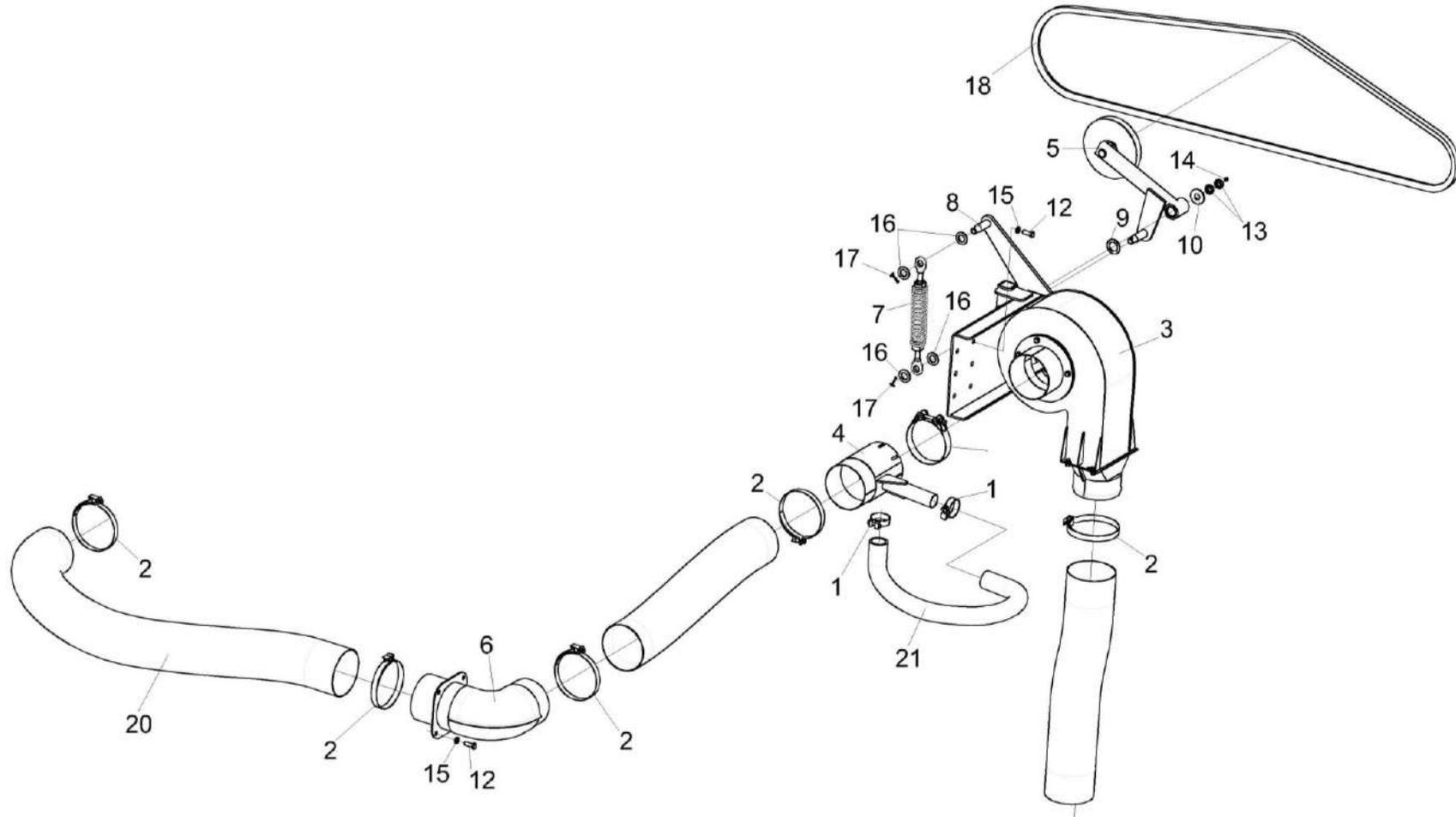
Рисунок 74 - Установка вентилятора отсоса пыли КВК-650-10-0150500
