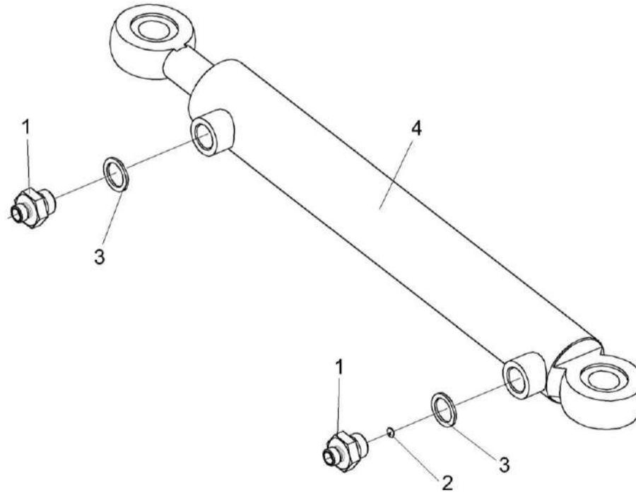
Рисунок 16 – Гидроцилиндр перемещения питающего аппарата КВК 0602520
