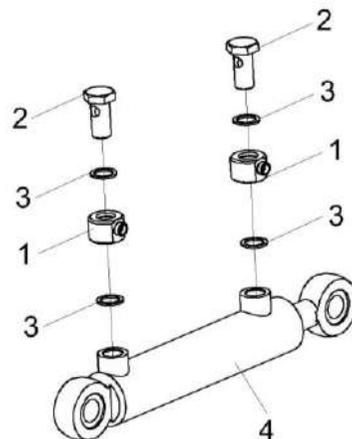
Рисунок 71 – Гидроцилиндр подъема силосопровода КВК 0602510А
