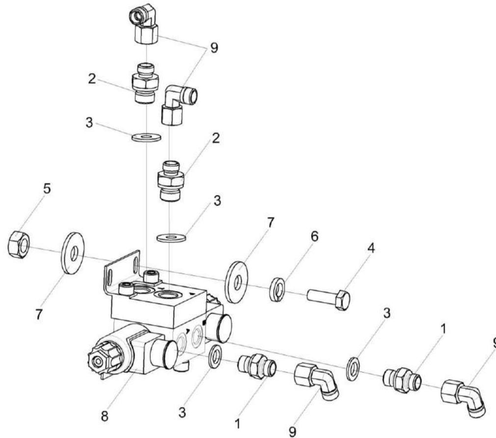
Рисунок 228 – Гидроблок доворота вала мотора ГСТ КВК-6-0601360
