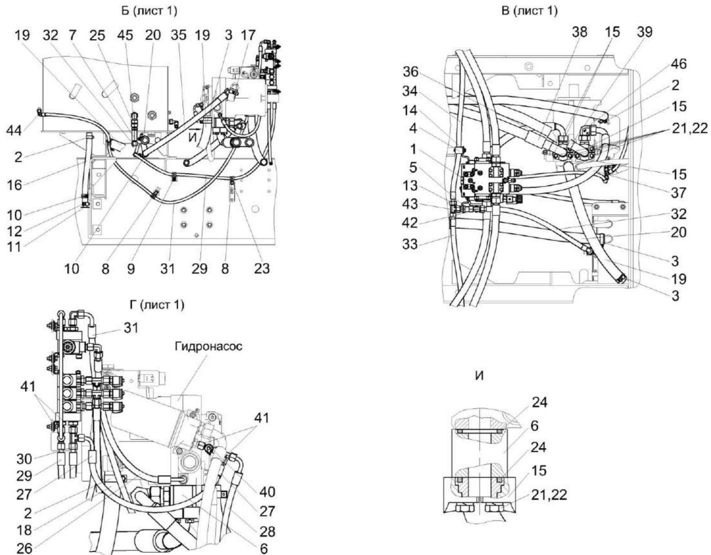
Рисунок 226 – Гидросистема привода ходовой части КВК-650-11-0601000 (лист 3)
