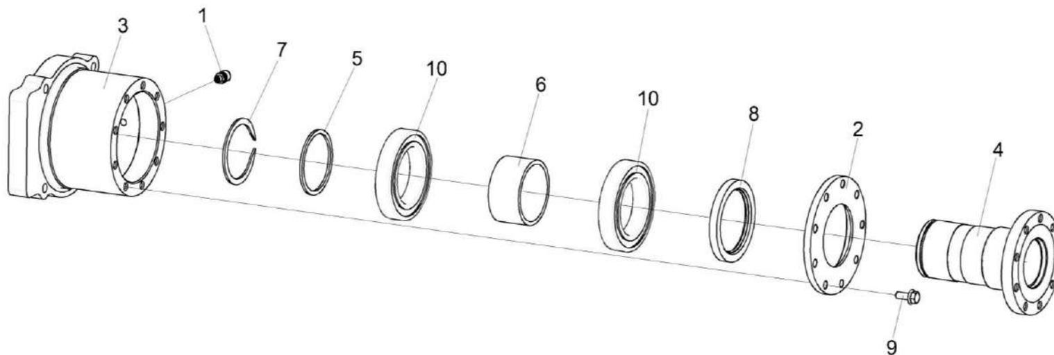
Рисунок 88 – Привод вентилятора КВС-6-0152030
