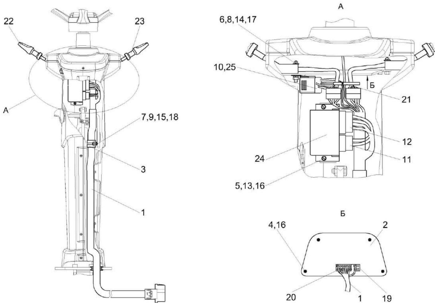
Рисунок 261 – Установка электрооборудования колонки рулевой КВК-650-11-0723000
