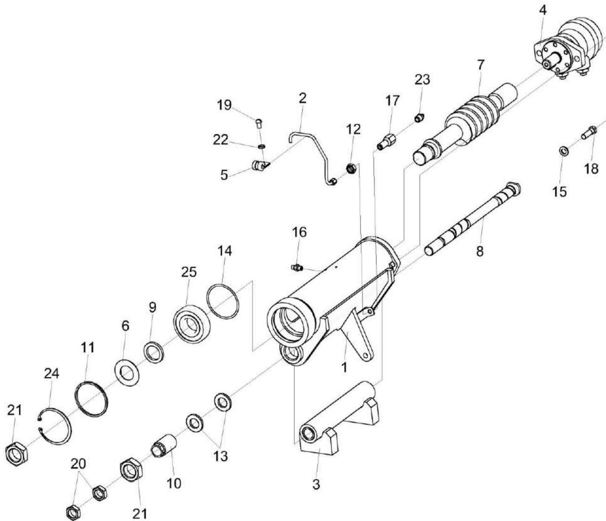
Рисунок 66 – Механизм поворота силопровода КВК 0143150
