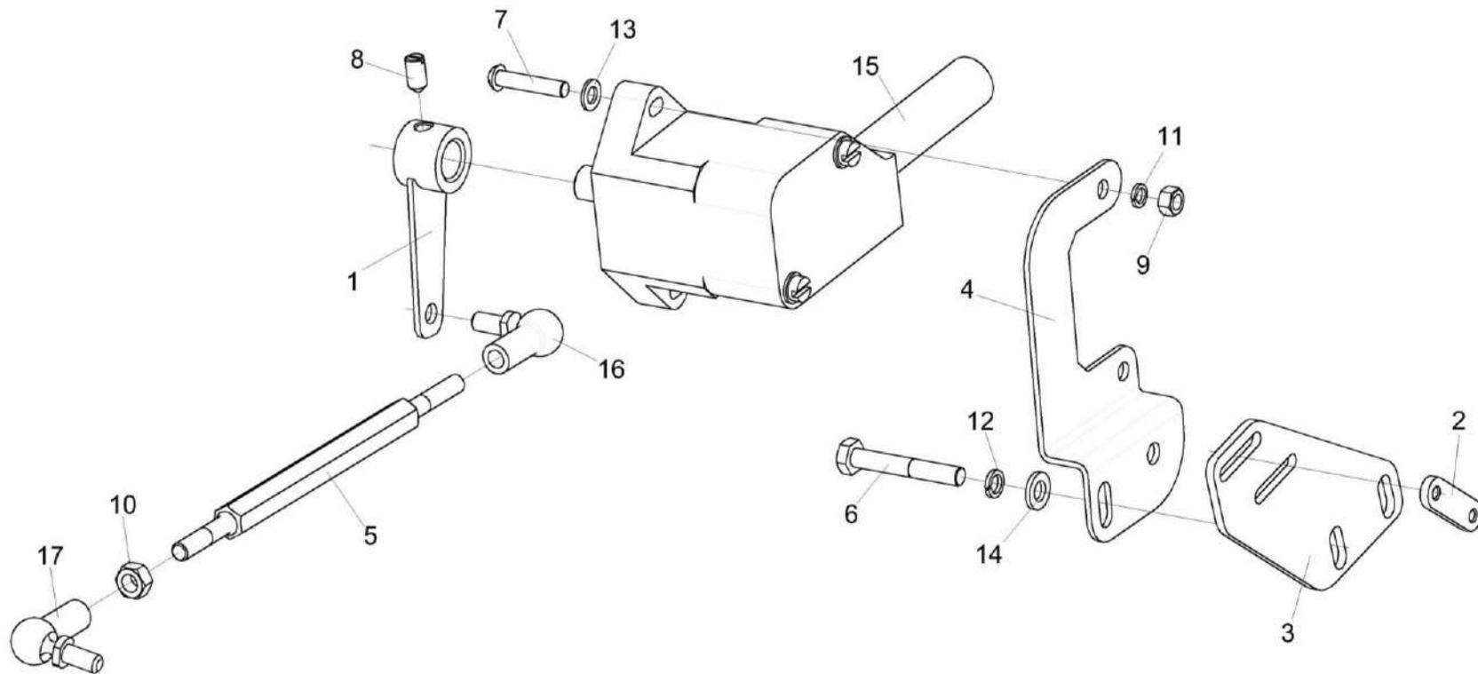
Рисунок 175 – Установка датчика УКК-01-0205800
