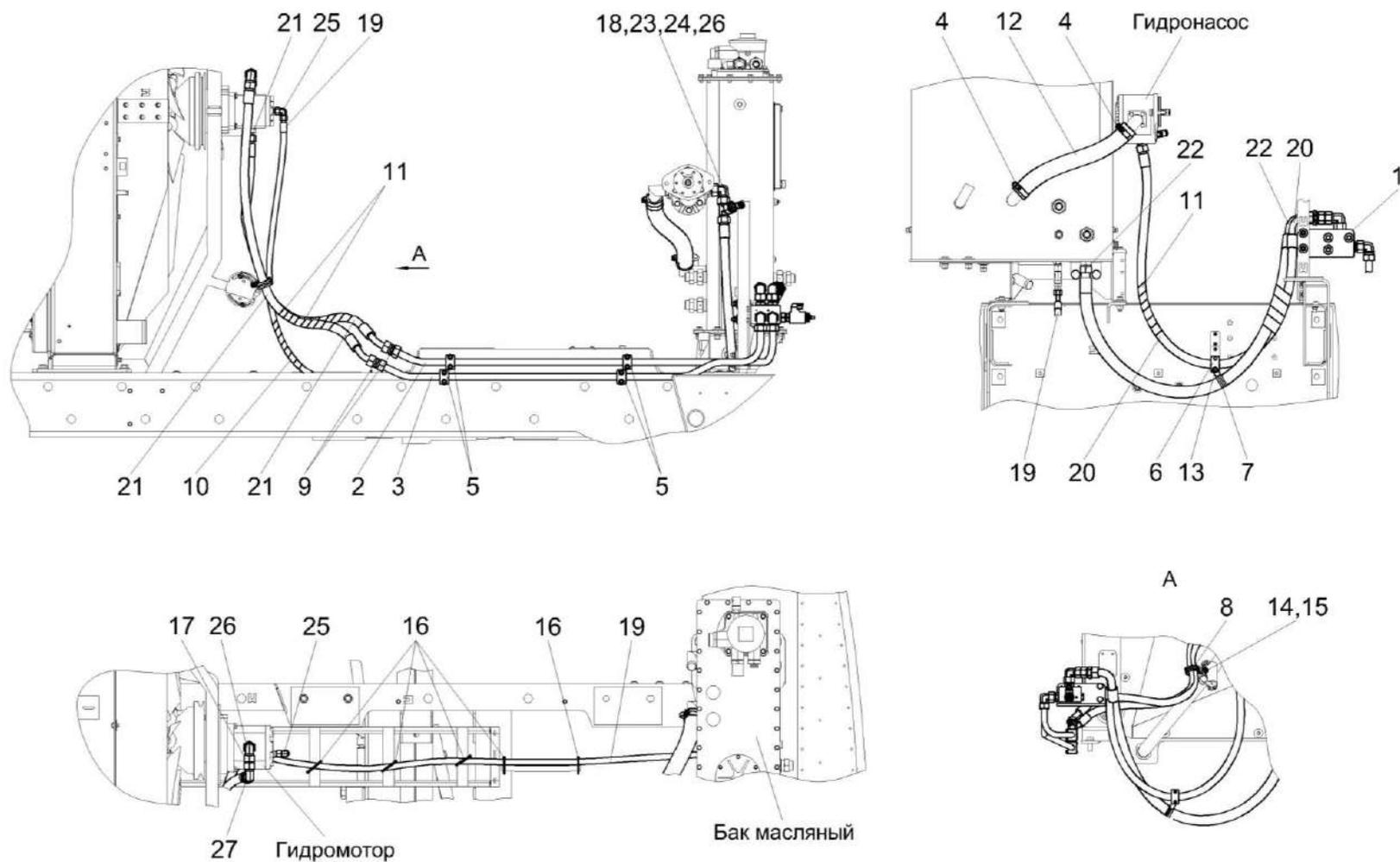
Рисунок 248 – Гидросистема привода вентилятора моторной установки КВК-650-11-0608000
