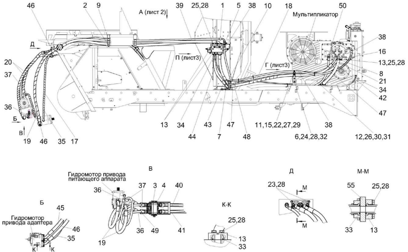
Рисунок 250 – Гидросистема привода питающего аппарата и адаптеров КВК-650-10-0604000 (лист 1)
