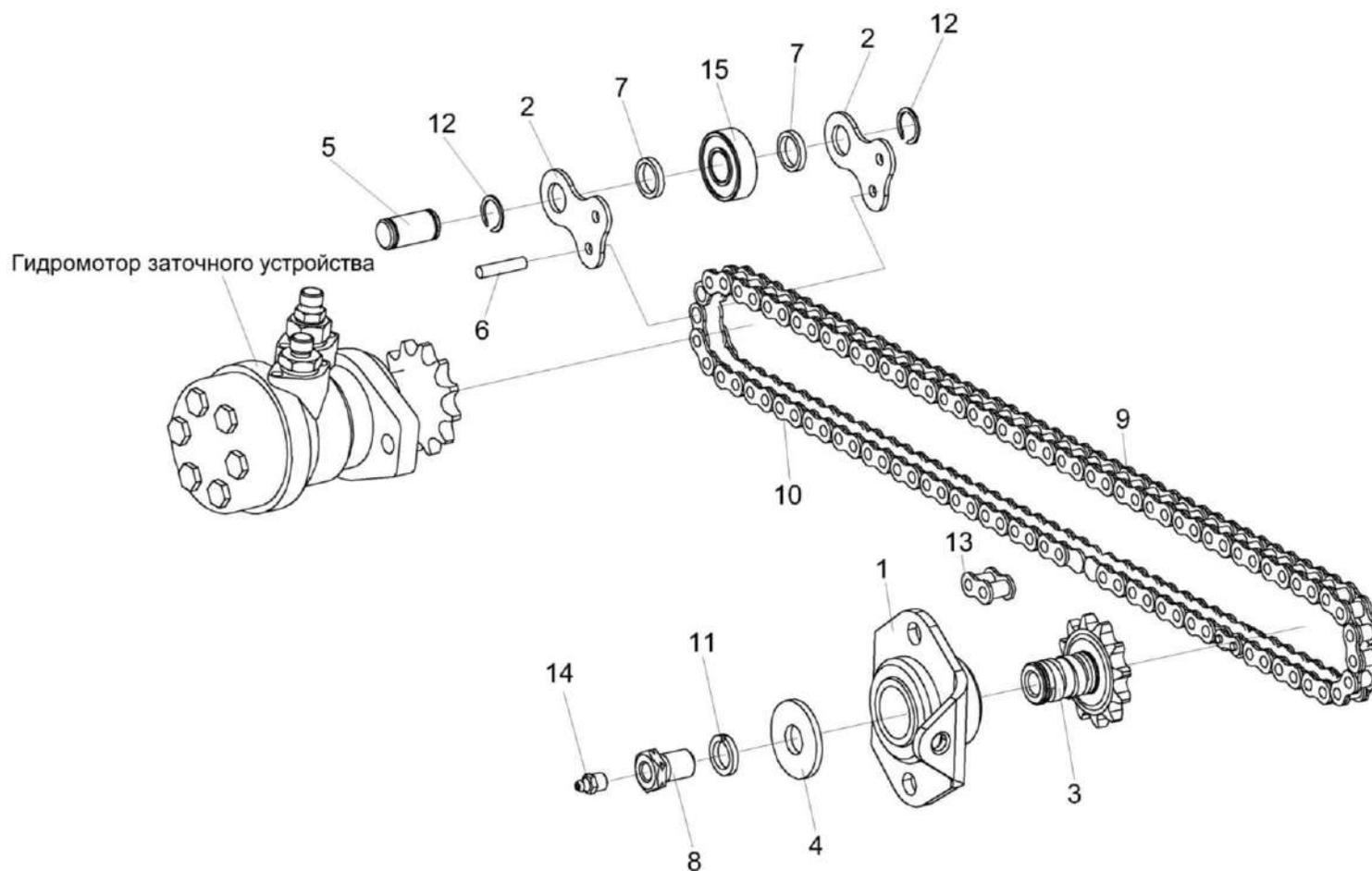
Рисунок 10 – Привод каретки КВК 0116050
