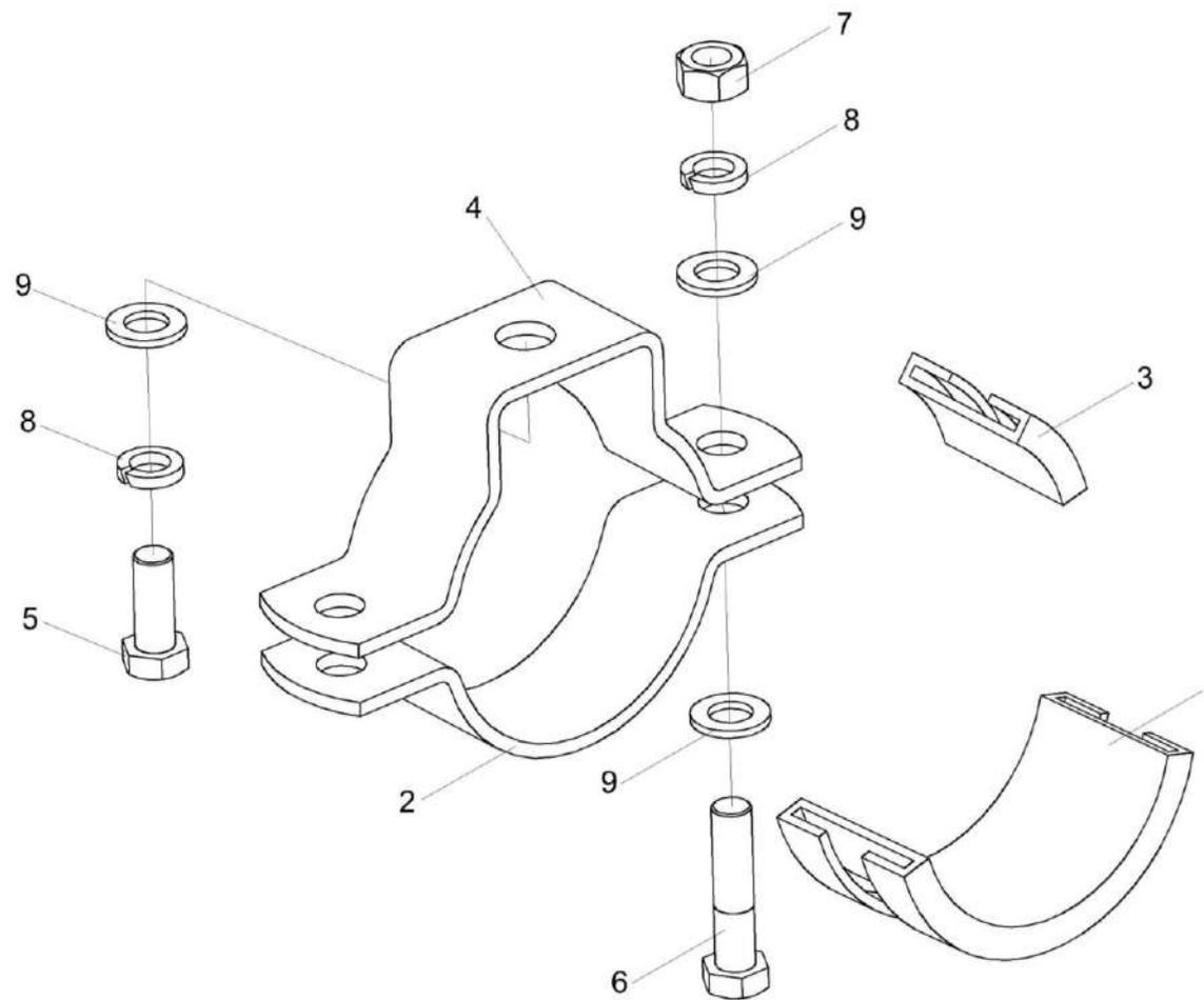
Рисунок 187 – Установка ресивера КЗК-8-3-0113050
