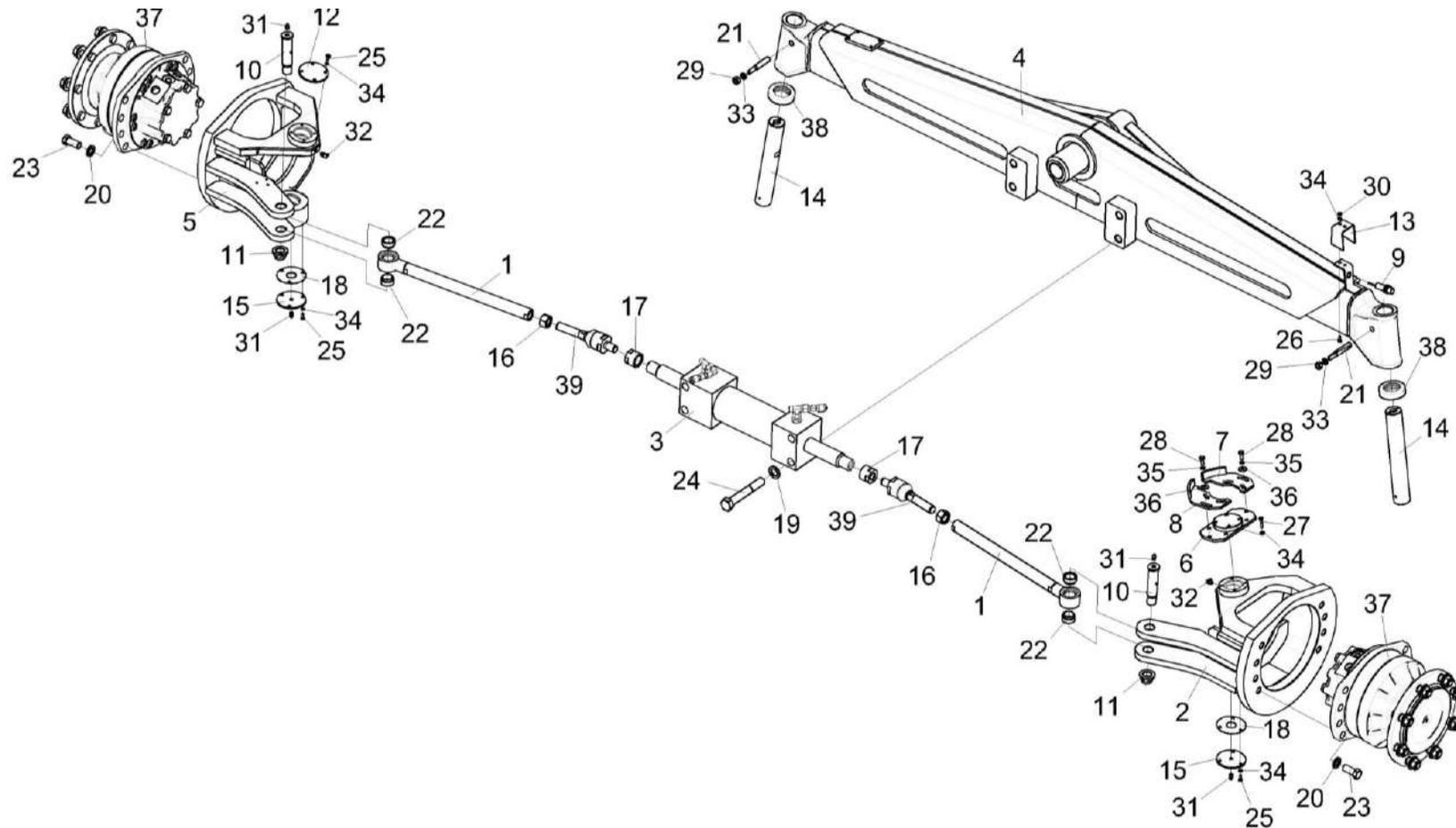
Рисунок 129 – Мост управляемых колес КВК-650-10-0109000
