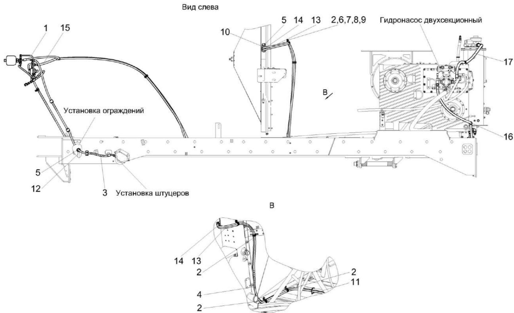
Рисунок 243 – Гидросистема привода стояночного тормоза и пылесъемника КВК-650-11-0606000 (лист 3)
