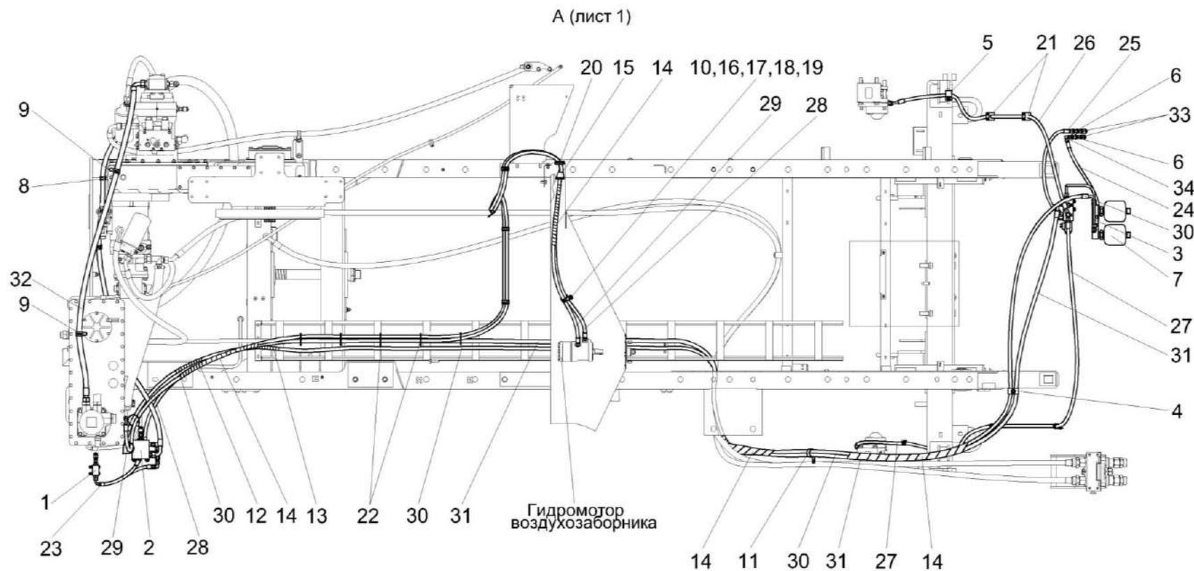
Рисунок 242 – Гидросистема привода стояночного тормоза и пылесъемника КВК-650-11-0606000 (лист 2)
