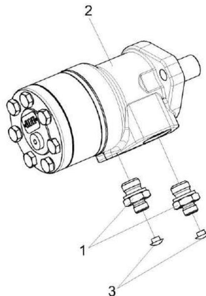
Рисунок 91 – Гидромотор воздухозаборника КВК 0602120
