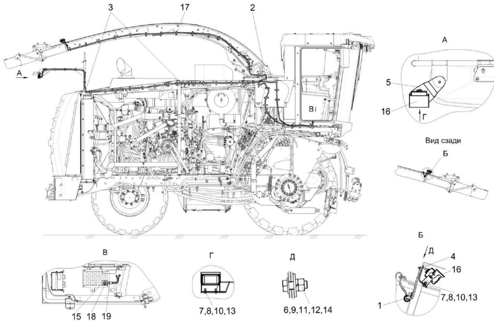
Рисунок 272 – Установка видеосистемы КВК-650-10-0701720
