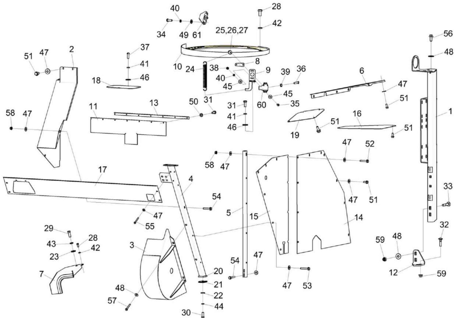
Рисунок 147 – Установка ограждений КВК-650-10-0100040 (лист 1)
