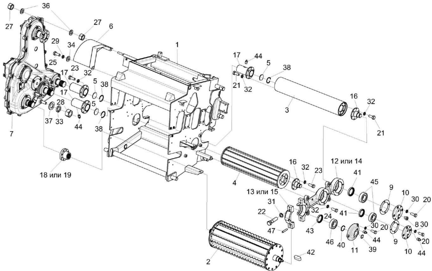
Рисунок 23 – Установка валцов нижних
