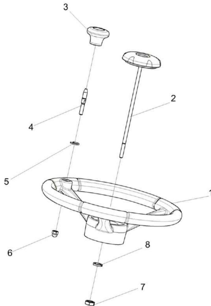
Рисунок 167 – Установка колеса рулевого КЗК-12-0122600-02
