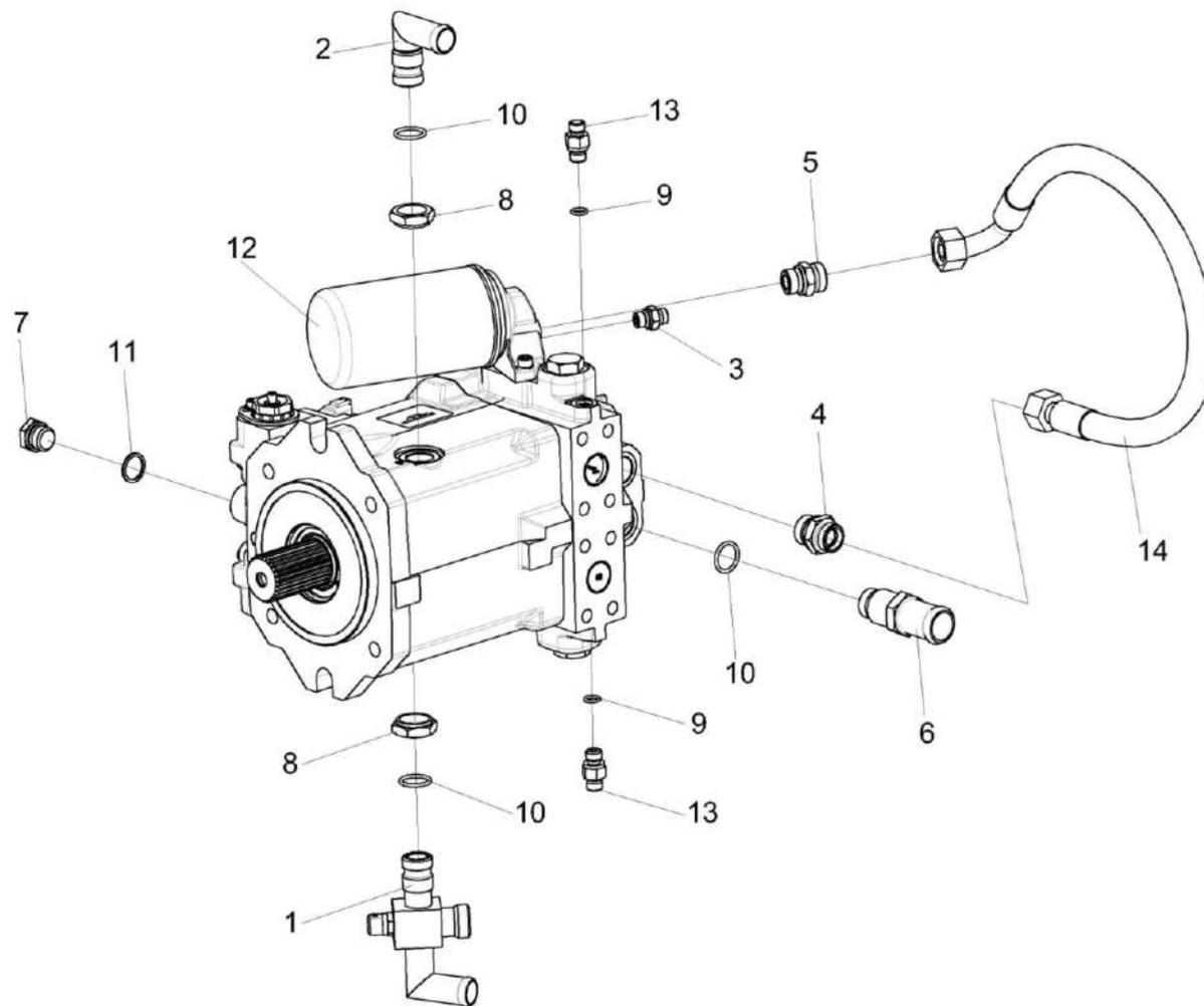
Рисунок 220 – Гидронасос КВК-650-10-0601100
