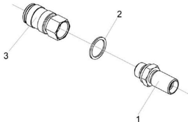
Рисунок 209 – Пневмовывод КНС-6028-0180110
