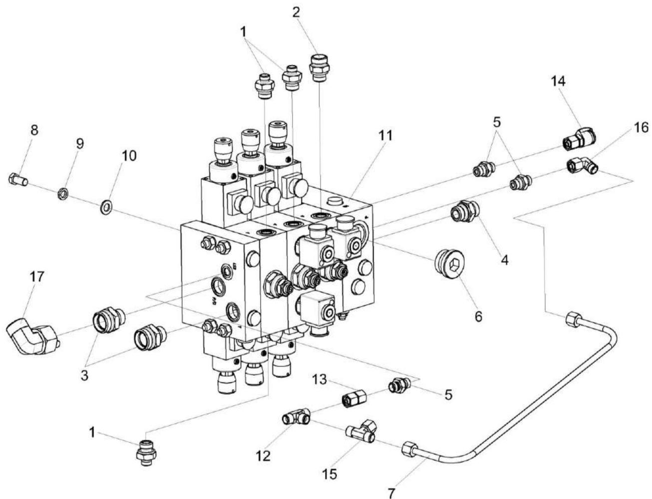
Рисунок 235 – Гидроблок КВК-650-11-0602300
