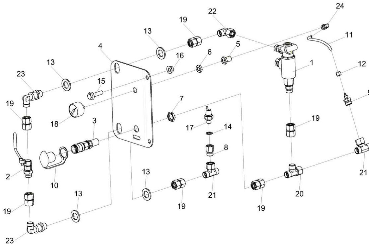
Рисунок 199 – Установка арматуры КВК-650-10-0800910
