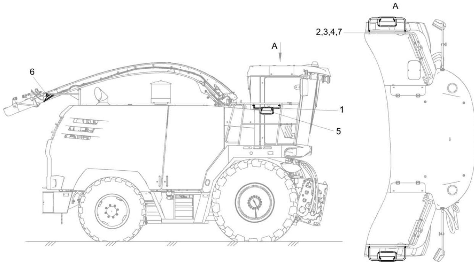
Рисунок 155 – Установка зеркал КВК-650-10-0100270
