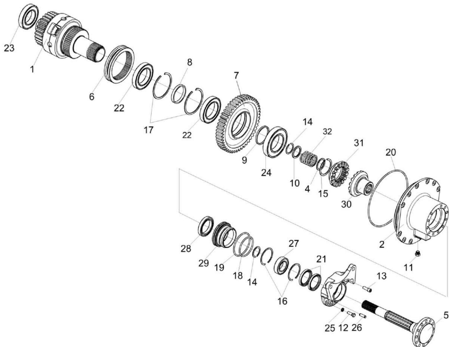
Рисунок 121 – Блок дифференциала КВК-6-0107080
