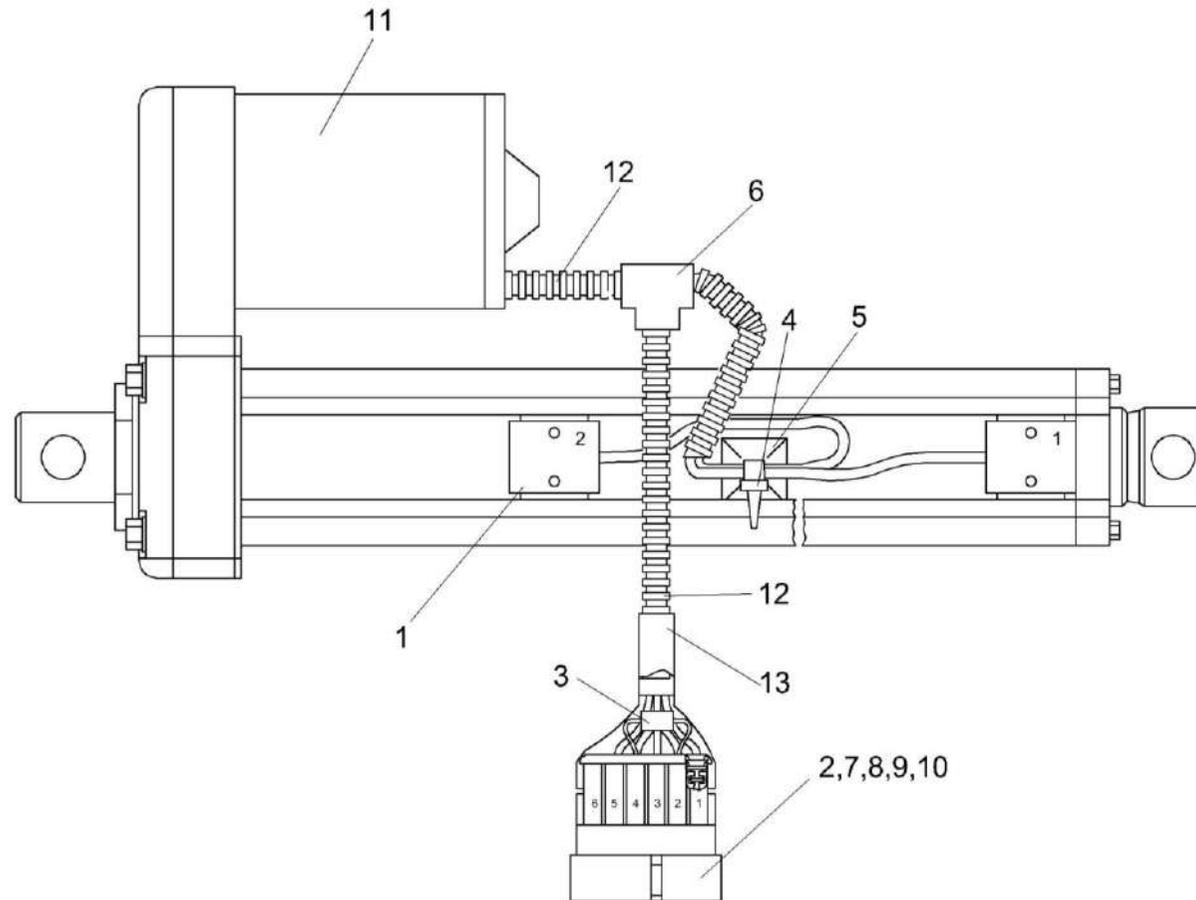
Рисунок 13 – Электромеханизм крышки заточного устройства КВК 0701610
