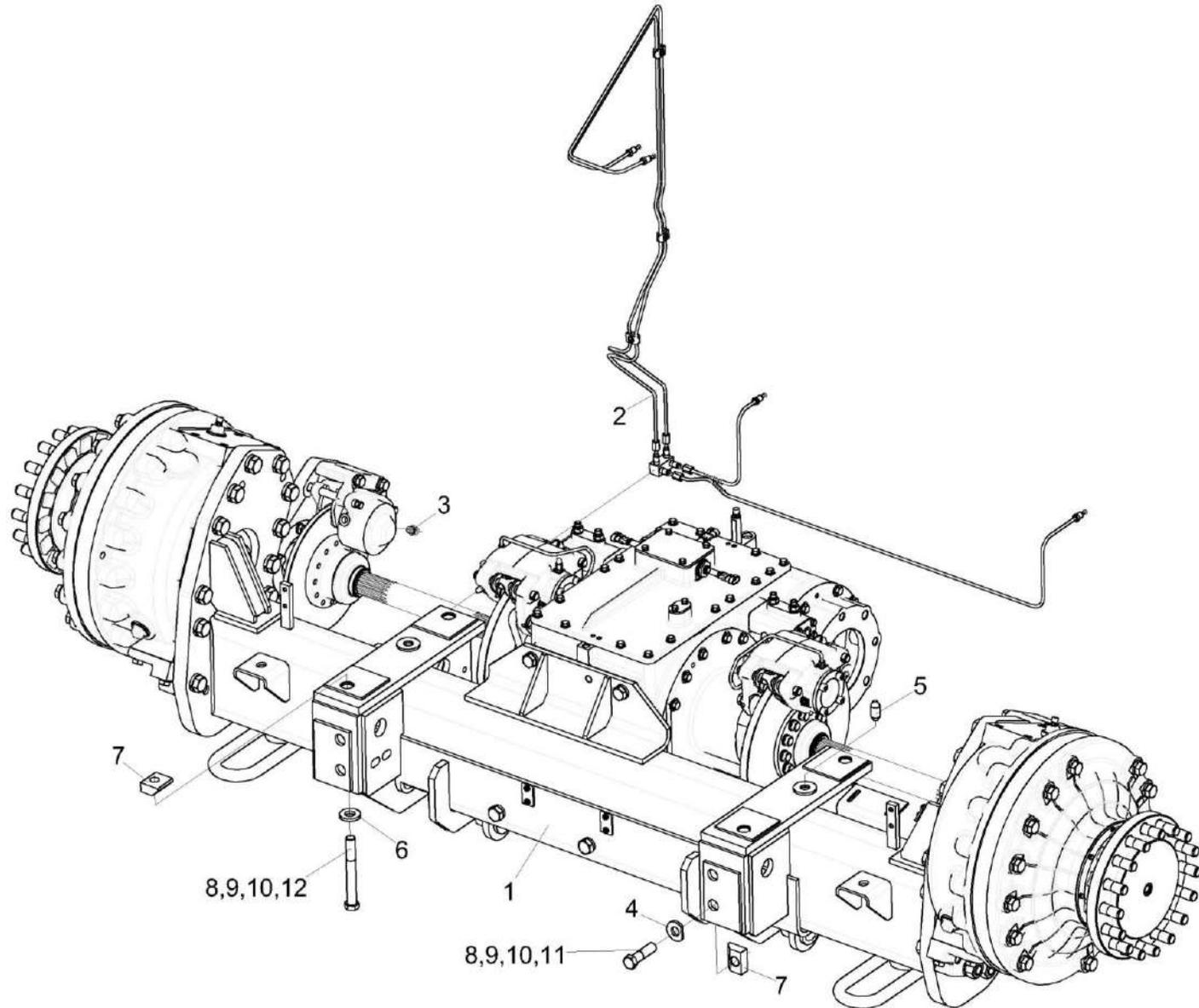
Рисунок 109 – Установка моста ведущих колес КВК-650-11-0101500 и КВК-650-11-0101500-01
