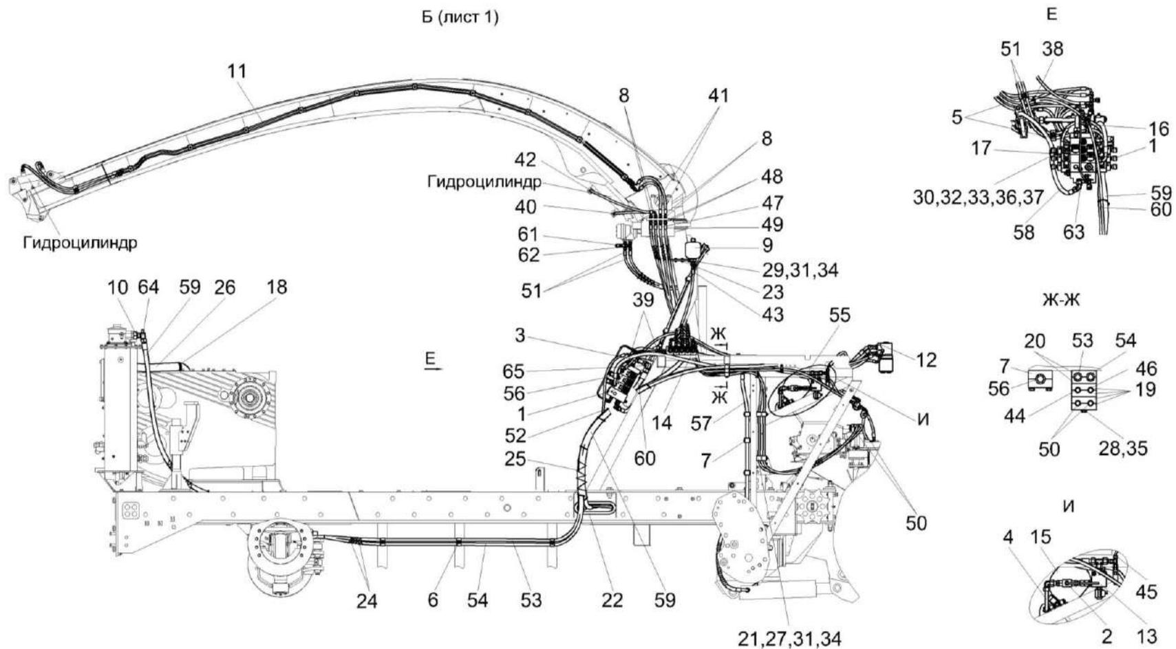
Рисунок 232 – Гидросистема рулевого управления и силовых гидроцилиндров КВК-650-11-0602000 (лист 2)
