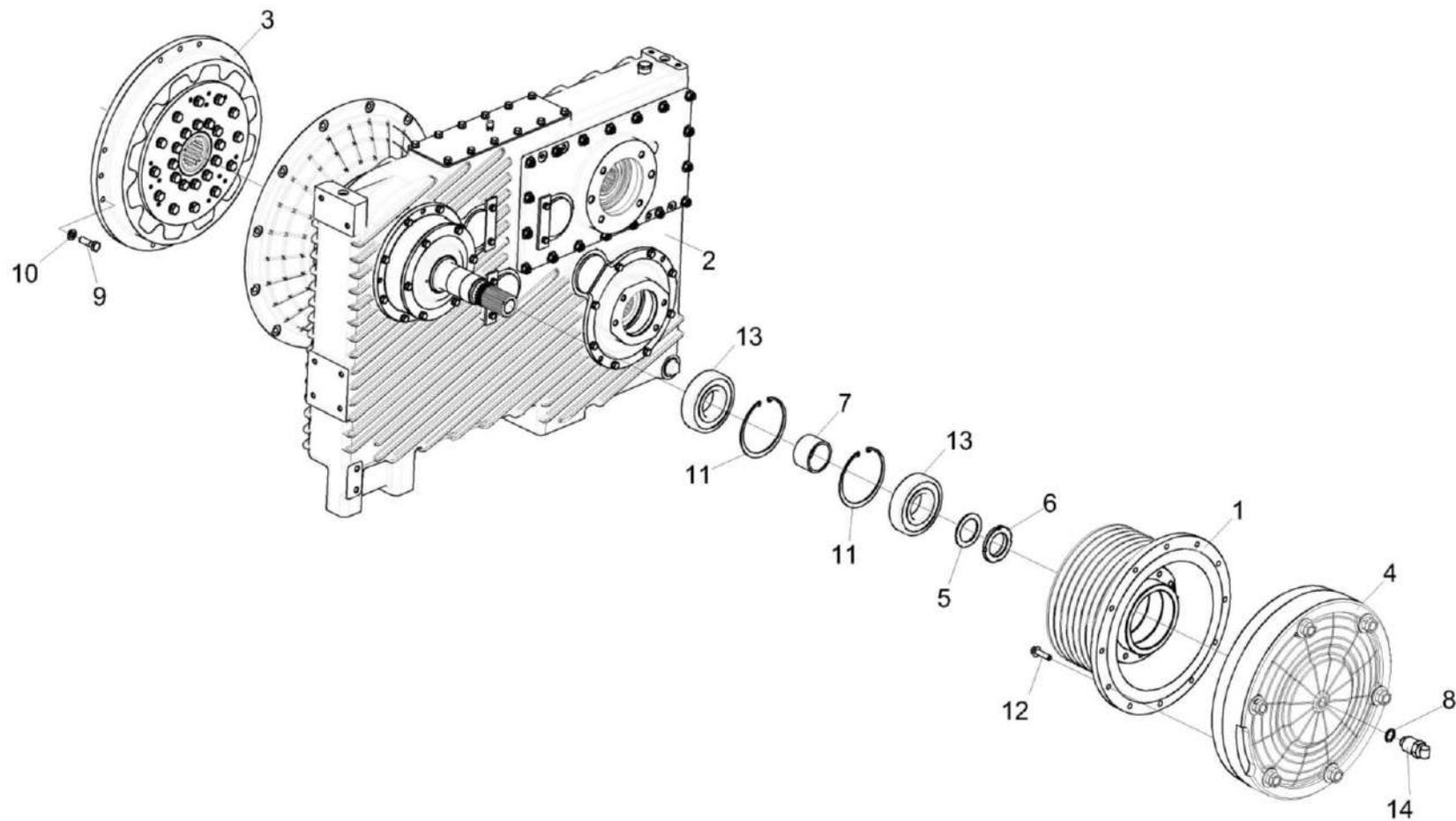
Рисунок 78 - Установка главного привода КВК-650-10-0151000
