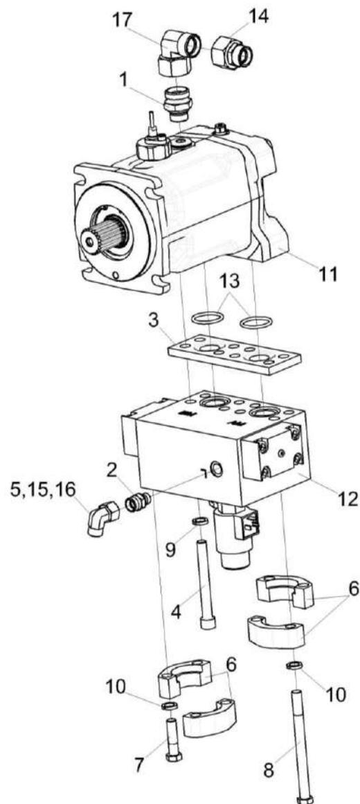
Рисунок 41 – Гидромотор привода питающего аппарата КВК-650-10-0604200
