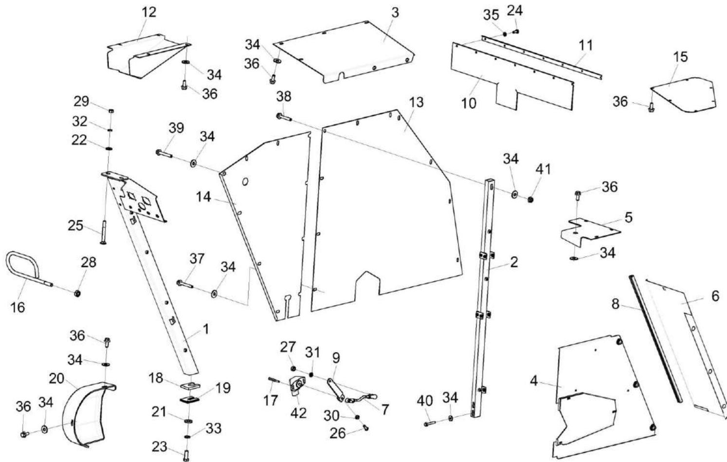
Рисунок 148 – Установка ограждений КВК-650-10-0100040 (лист 2)
