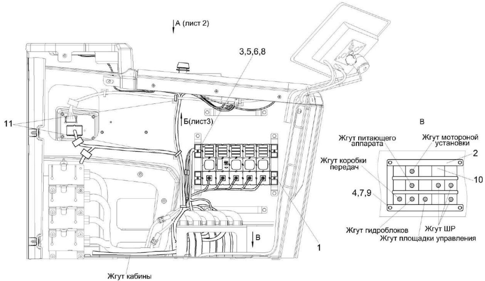
Рисунок 262 – Установка электрооборудования пульта управления КВК-650-11-0725000 (лист 1)
