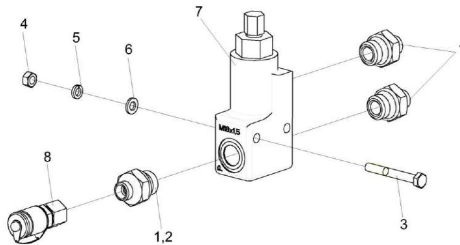
Рисунок 244 – Клапан предохранительный КВК-650-10-0606300
