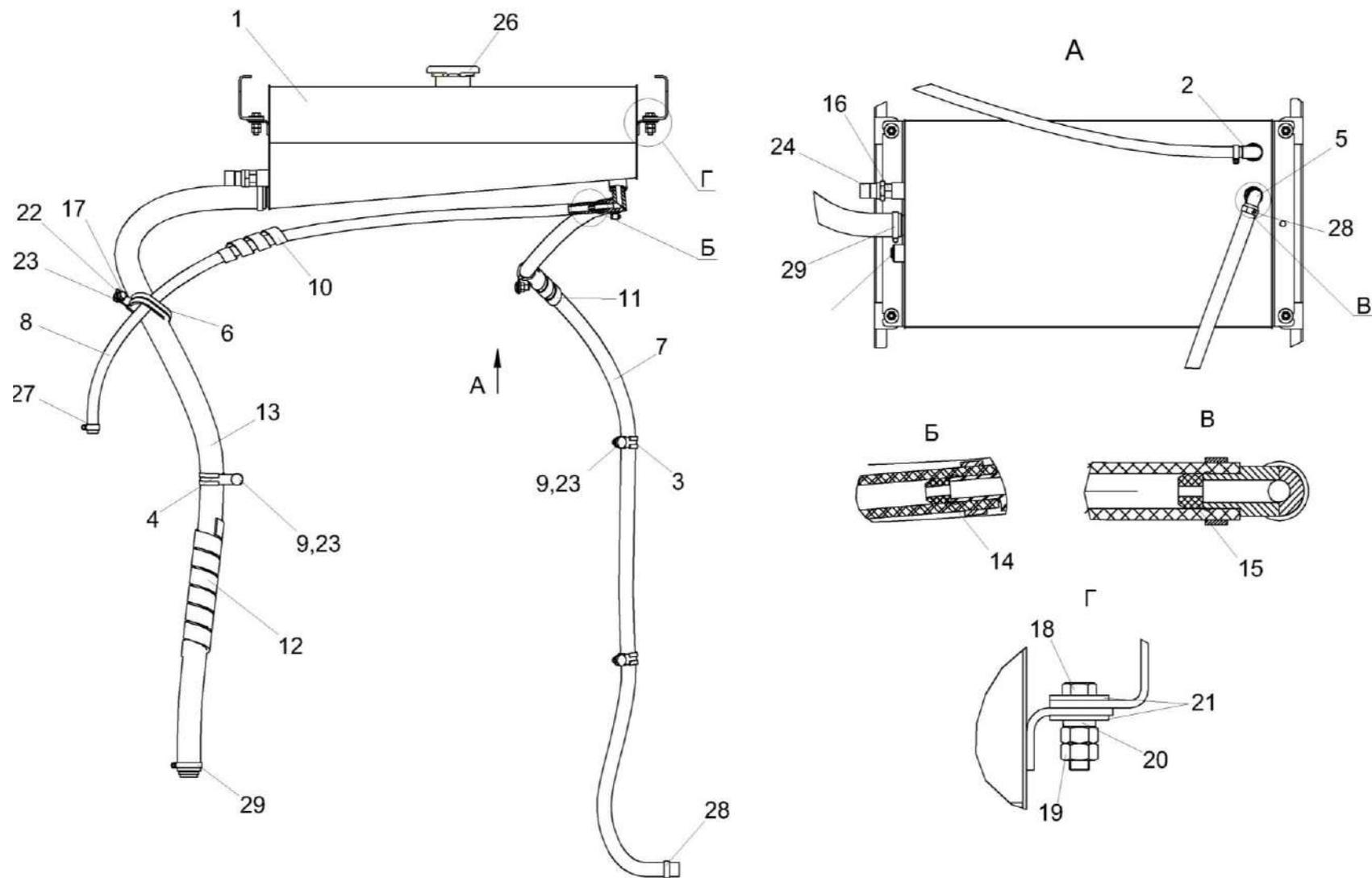
Рисунок 99 – Установка бачка расширительного КВК-650-11-0154000
