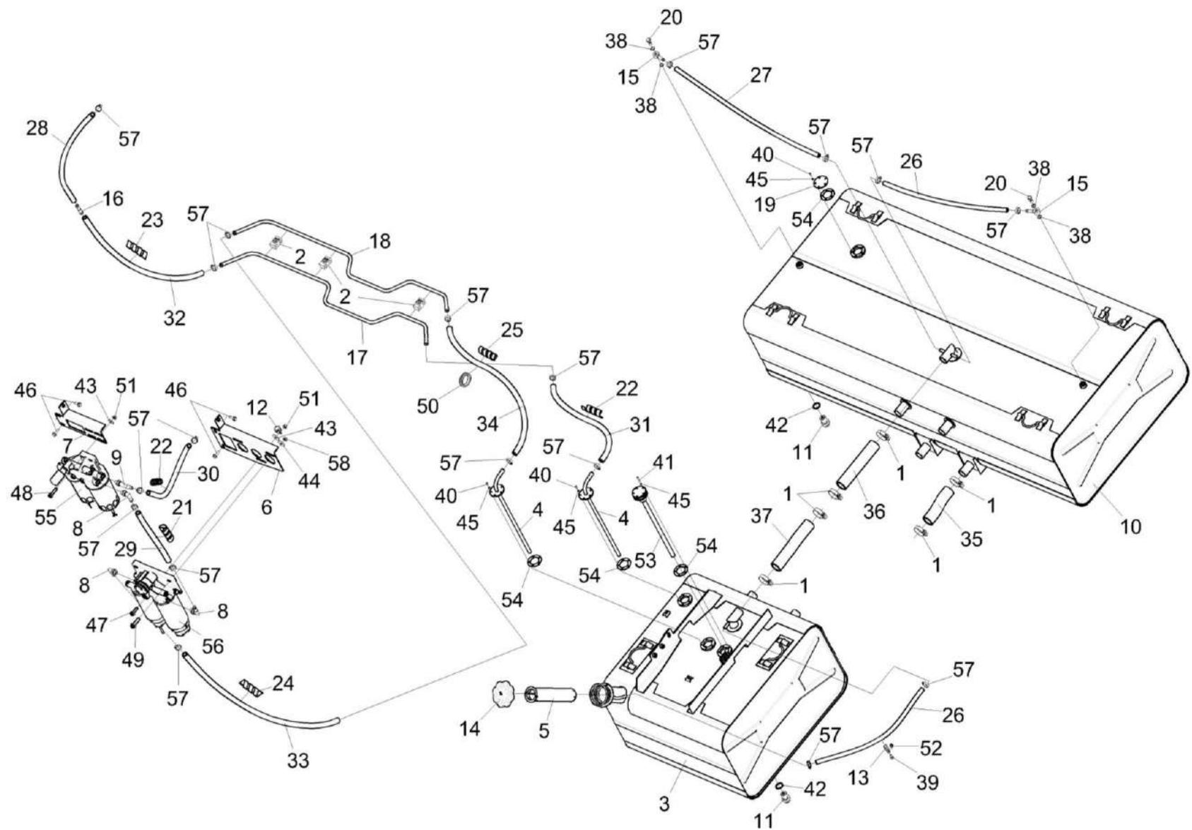
Рисунок 102 – Установка топливного оборудования КВК-650-11-0103000 (Лист 1)
