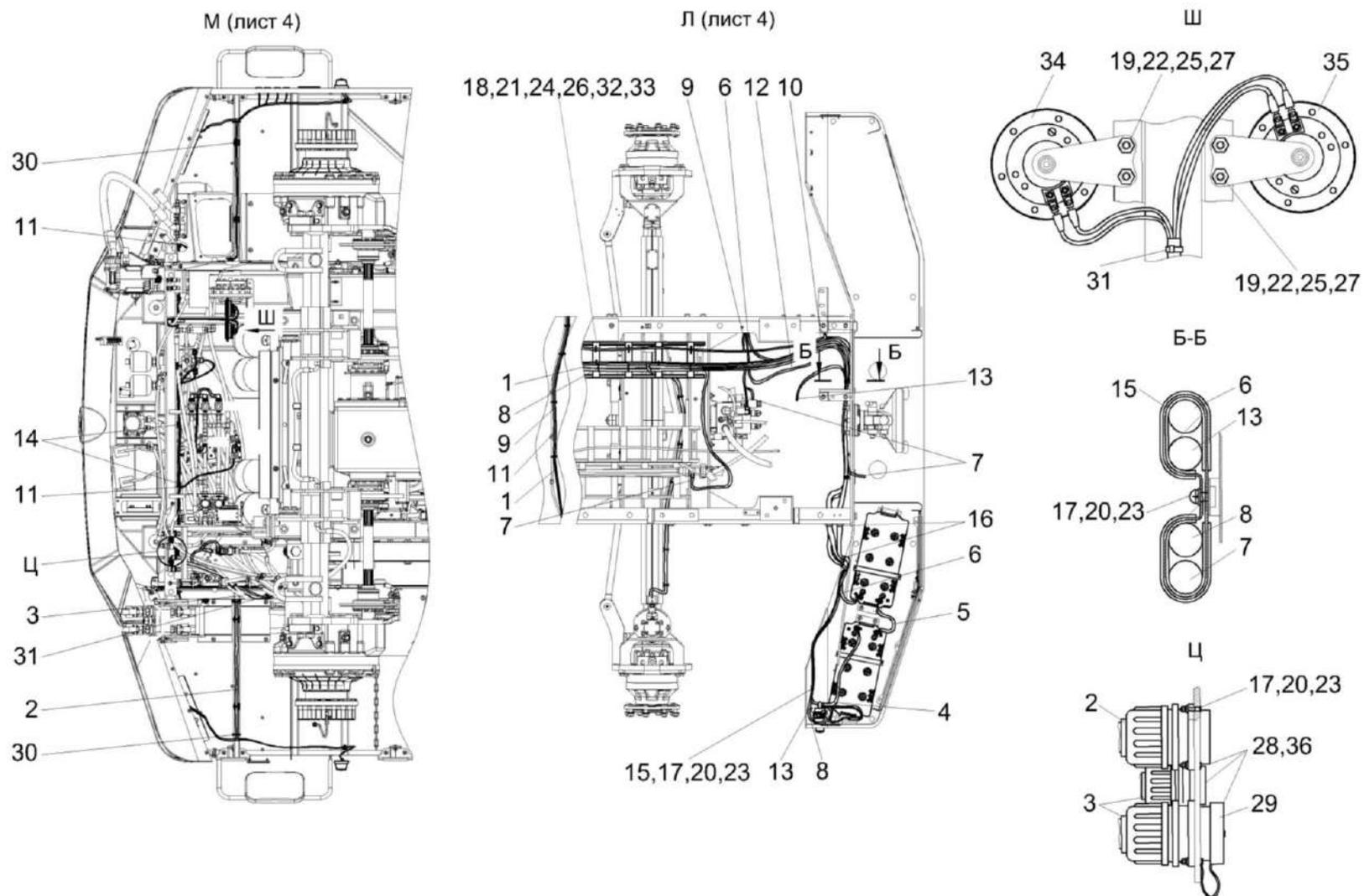
Рисунок 259 – Установка электрооборудования комбайна КВК-650-11-0721000 (лист 5)
