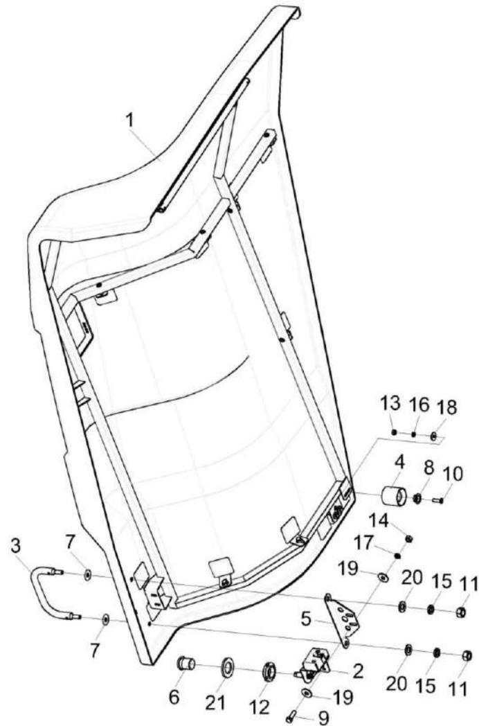
Рисунок 139 – Капот КВК-650-10-0160100 и КВК-650-10-0160100-01 (зеркальное отражение)
