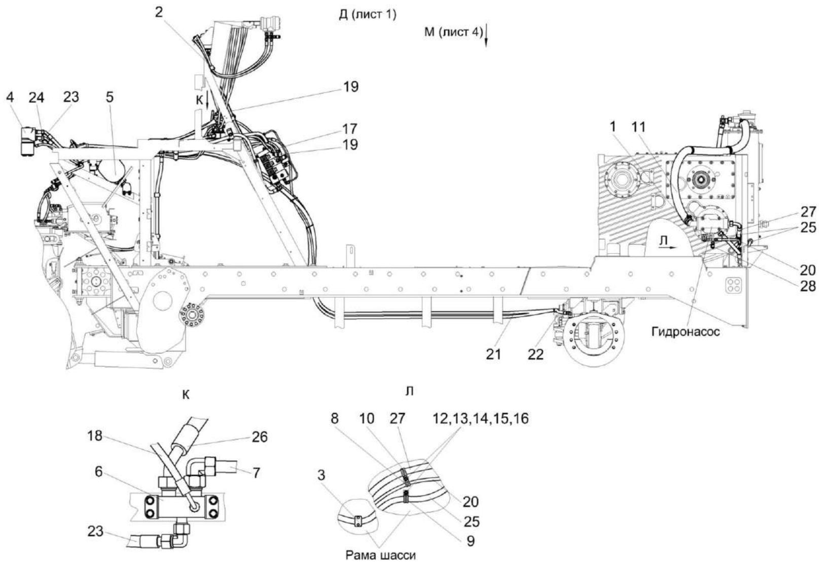
Рисунок 233 – Гидросистема рулевого управления и силовых гидроцилиндров КВК-650-11-0602000 (лист 3)
