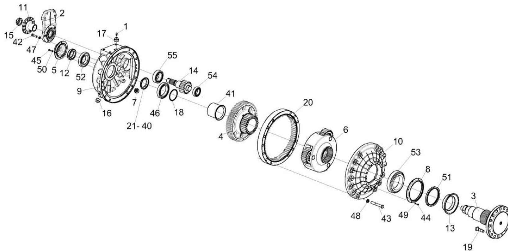
Рисунок 115 – Редуктор бортовой КВК-650-10-0107020, КВК-650-10-0107020-01,
