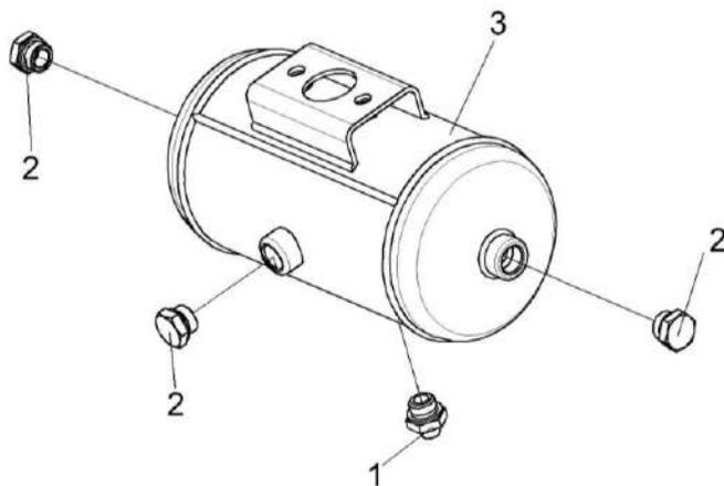
Рисунок 210 – Ресивер регенерации УЭС-16-0800070
