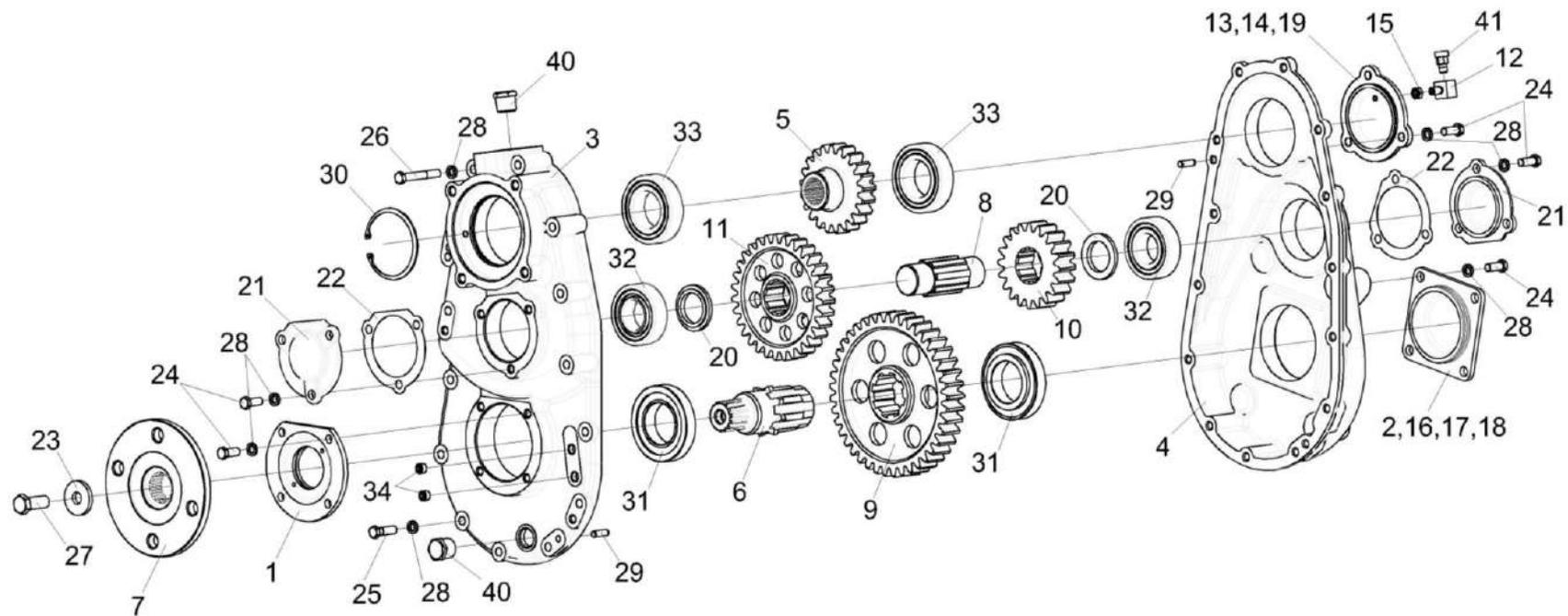
Рисунок 40 – Редуктор КВК-650-10-0104000
