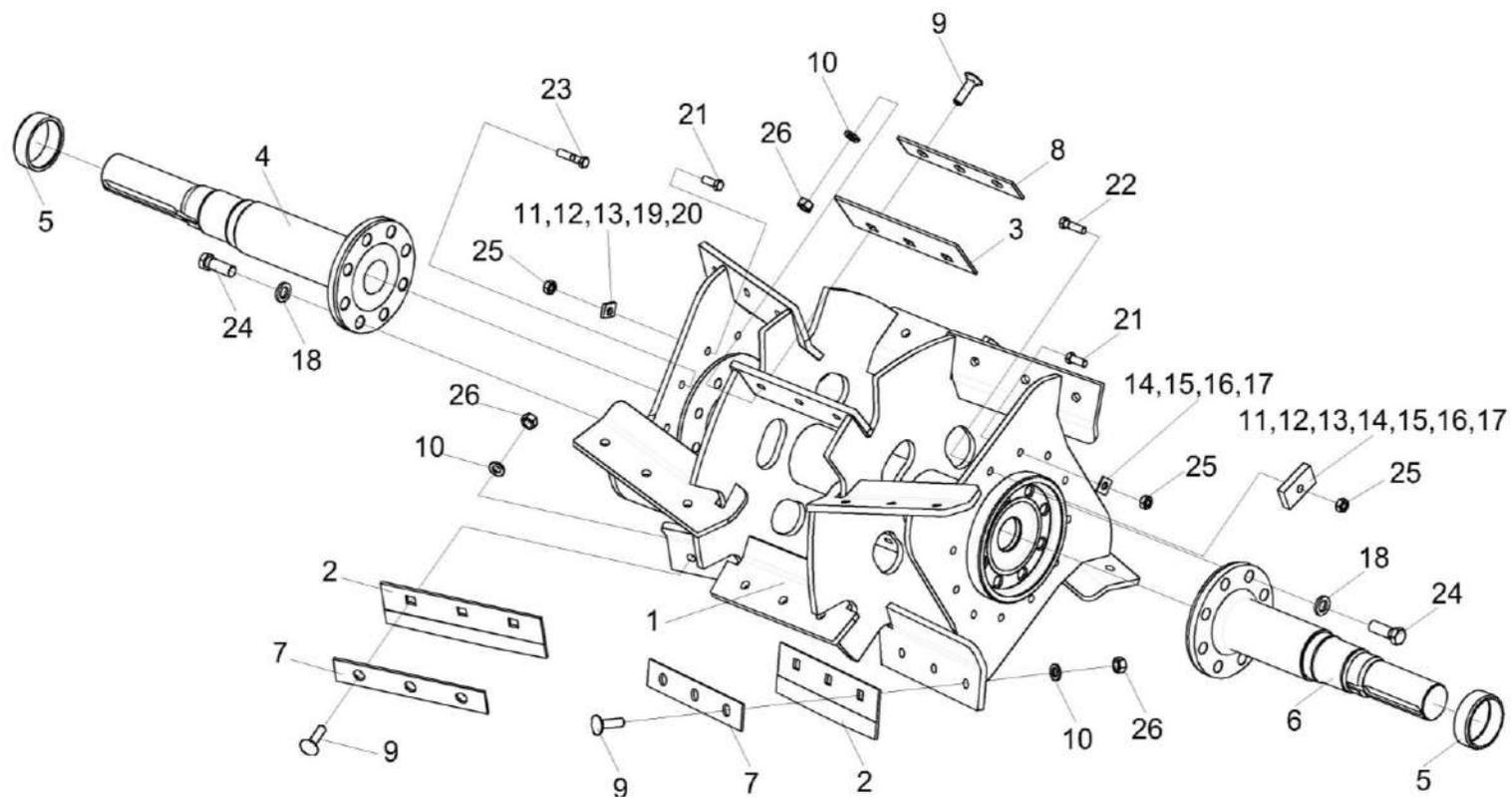
Рисунок 62 – Вал ускорителя выброса КВК-650-10-0142210
