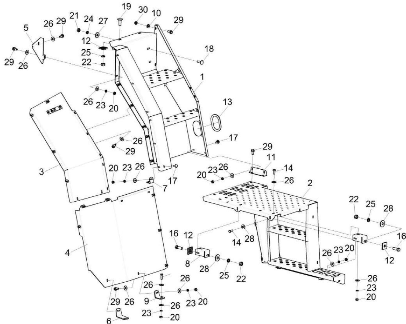
Рисунок 152 – Установка трапа КВК-650-10-0172000
