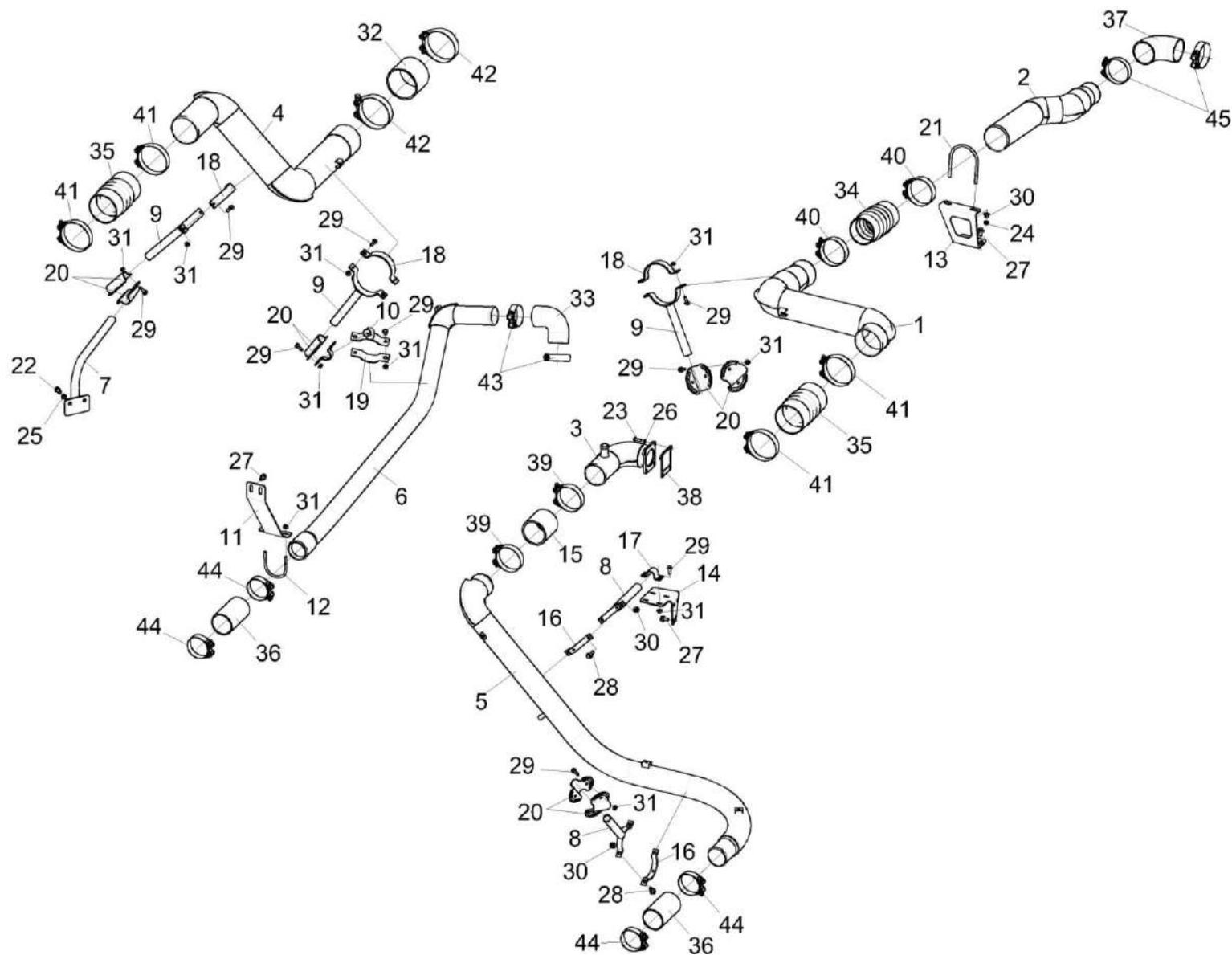
Рисунок 97 – Установка труб КВК-650-11-0150200
