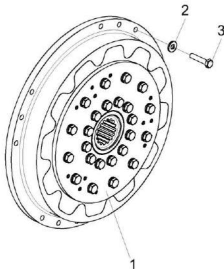
Рисунок 93 – Установка муфты КВК-650-11-0150030
