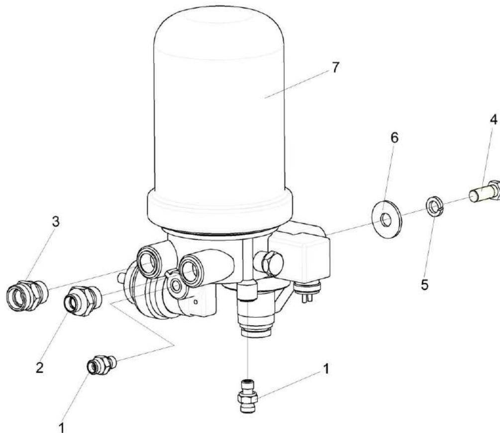
Рисунок 195 – Регулятор давления с адсорбером КВК-650-11-0800170
