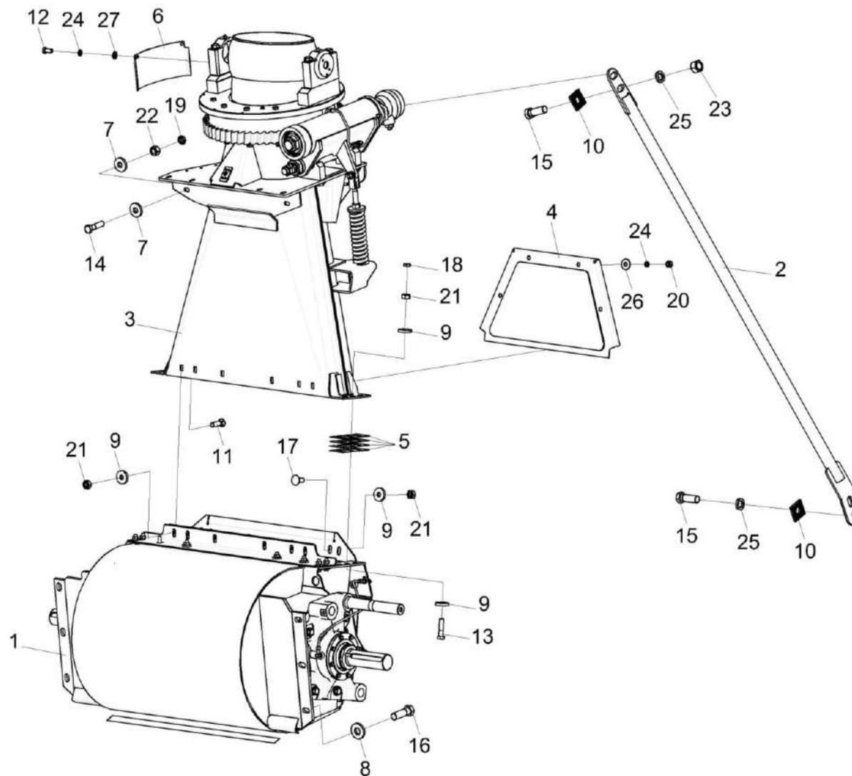
Рисунок 56 – Установка технологического тракта КВК-650-10-0140000 (лист 1)
