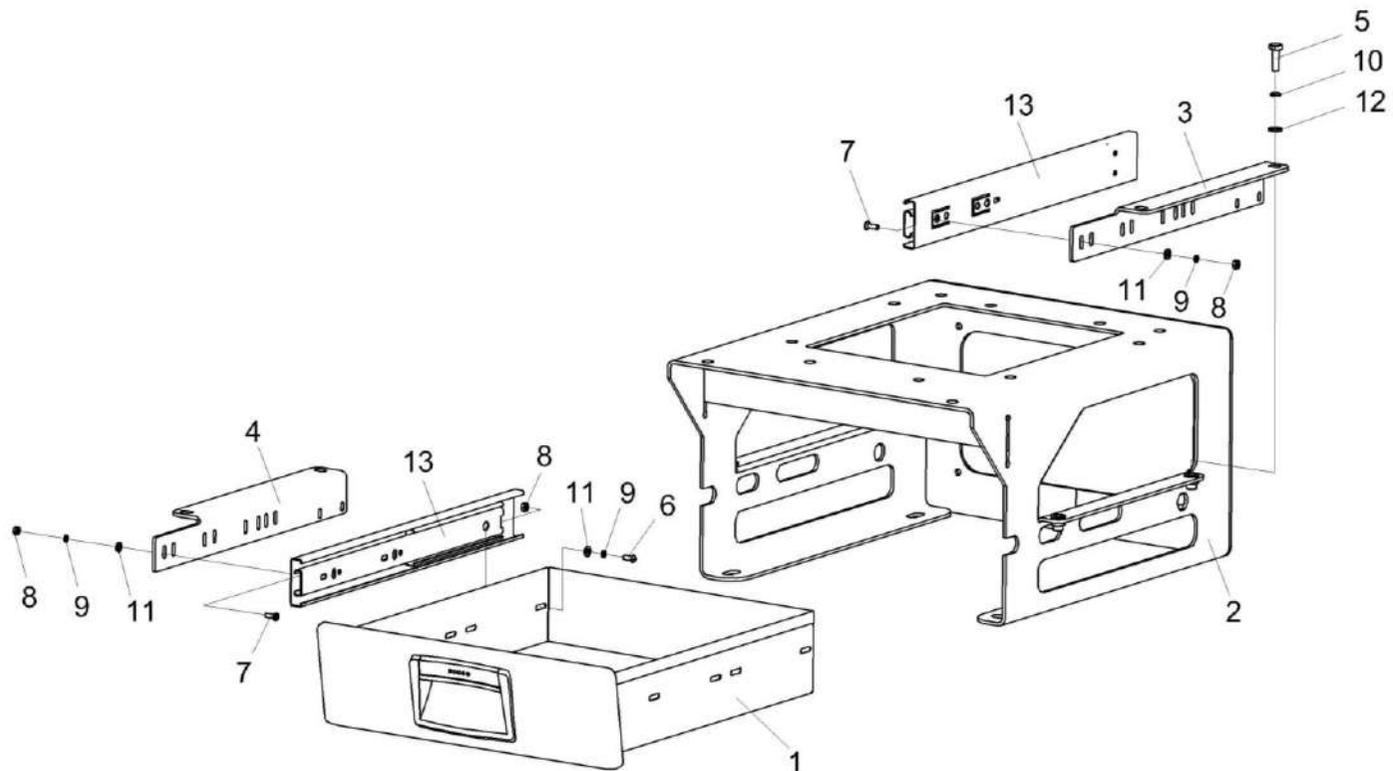
Рисунок 164 – Установка кронштейна УК3-01-0230010
