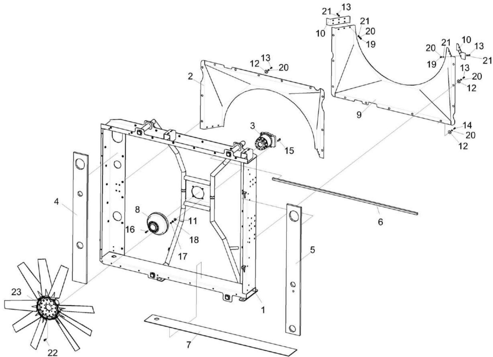
Рисунок 87 – Корпус радиаторов КВК-650-10-0152010
