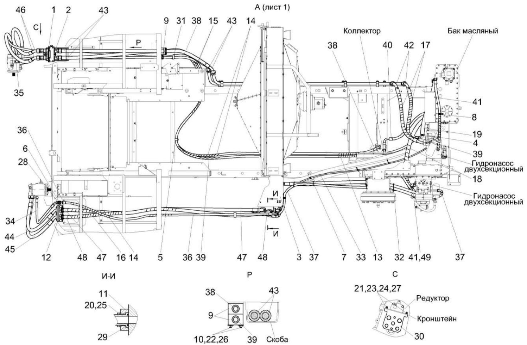
Рисунок 251 – Гидросистема привода питающего аппарата и адаптеров КВК-650-10-0604000 (лист 2)
