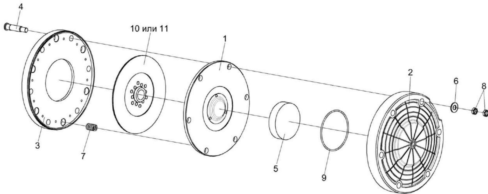
Рисунок 85 – Механизм нажимной КСК-6025-0116020
