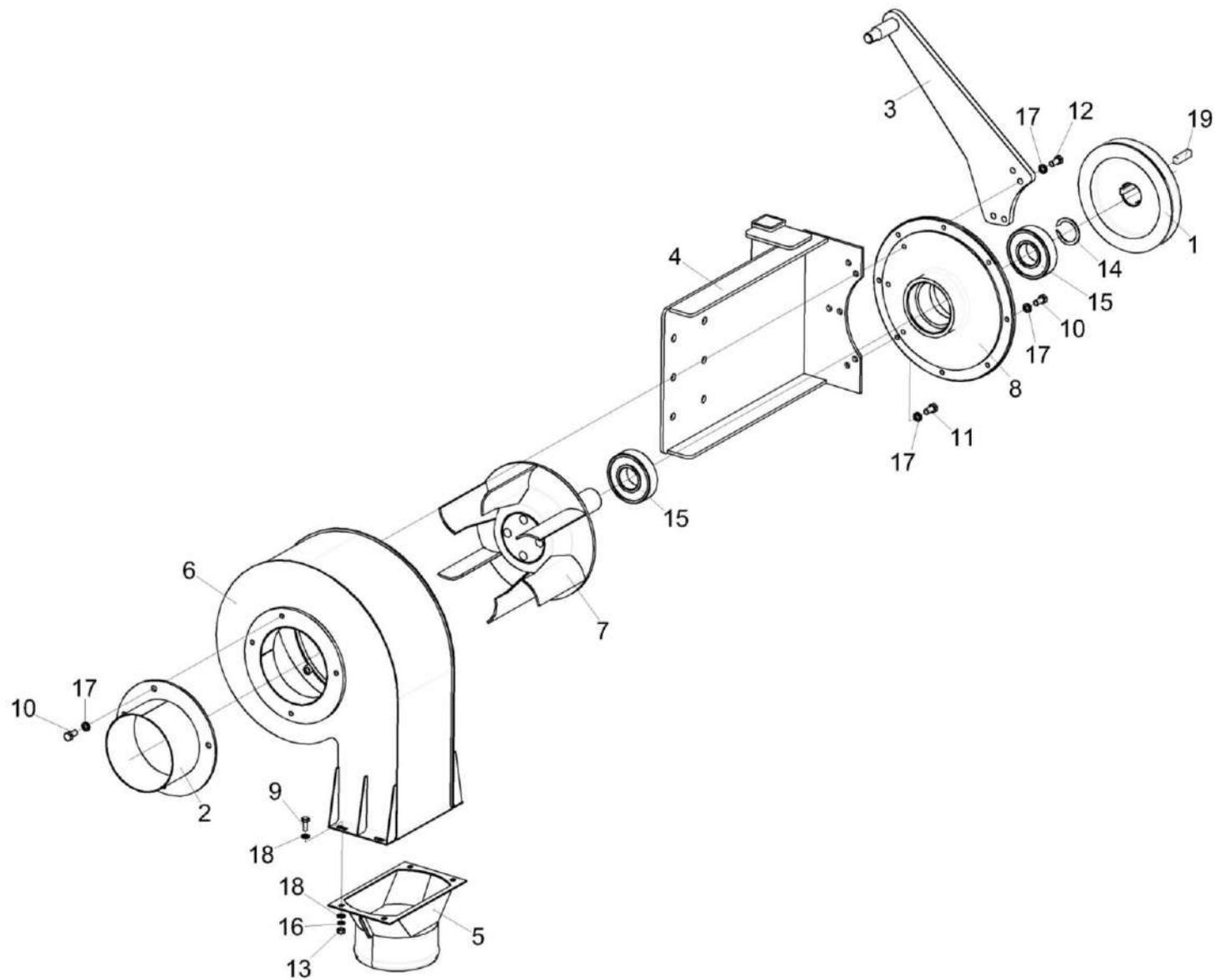
Рисунок 75 - Вентилятор КВК-650-10-0150410
