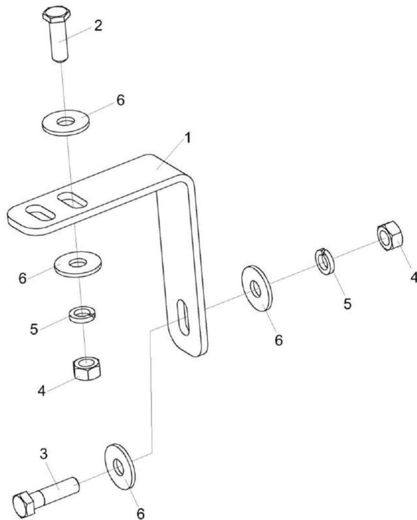
Рисунок 186 – Установка конденсатора КВС-8-0121080
