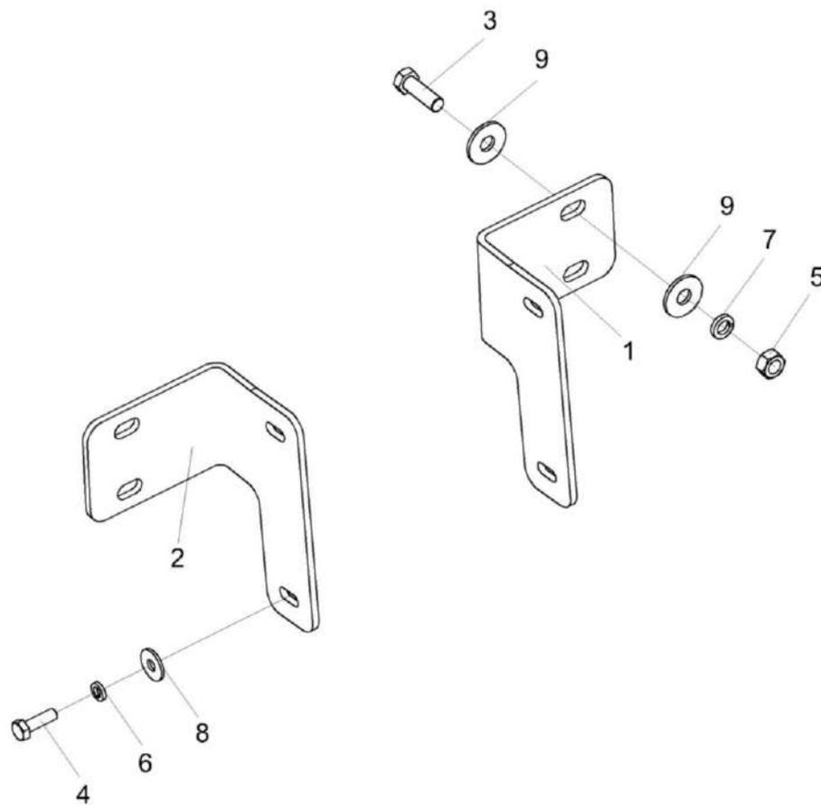
Рисунок 191 – Установка блока испарительно-отопительного КЗК-1420-0113060
