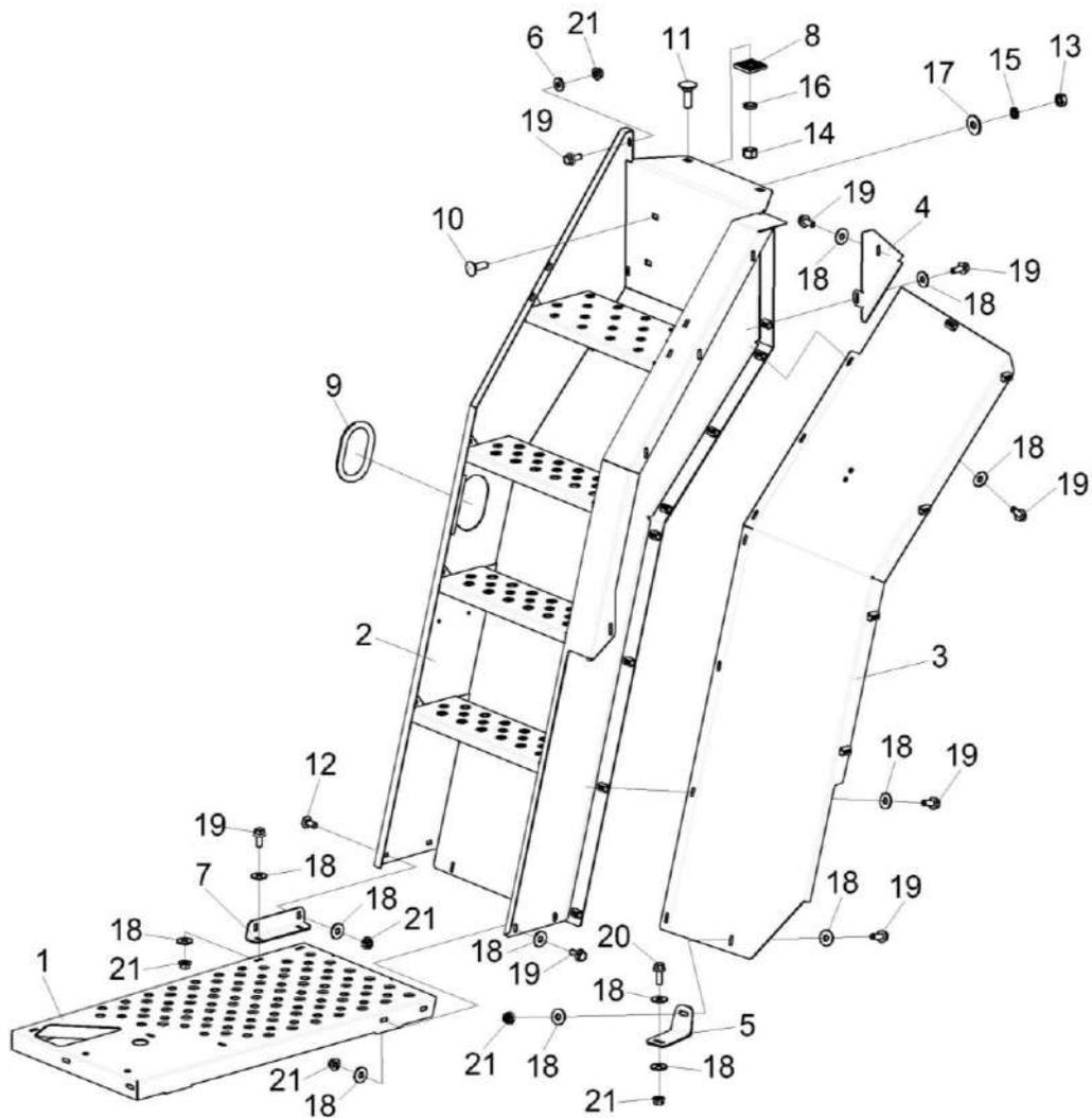
Рисунок 153 – Установка трапа КВК-650-10-0175000
