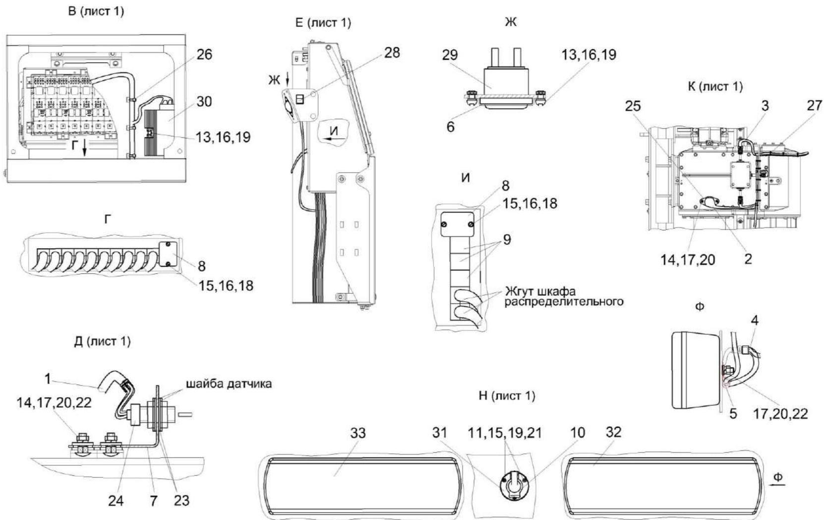
Рисунок 256 – Установка электрооборудования комбайна КВК-650-11-0721000 (лист 2)
