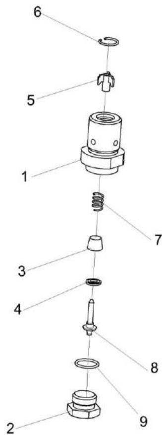
Рисунок 105 – Клапан сливной КВС-1-0103180
