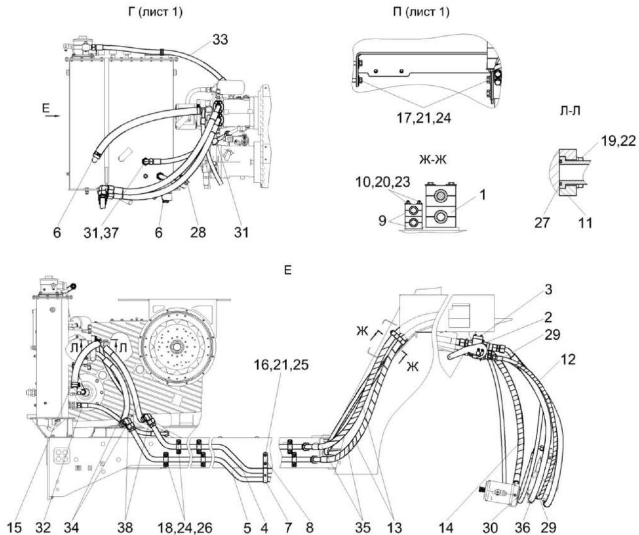
Рисунок 252 – Гидросистема привода питающего аппарата и адаптеров КВК-650-10-0604000 (лист 3)
