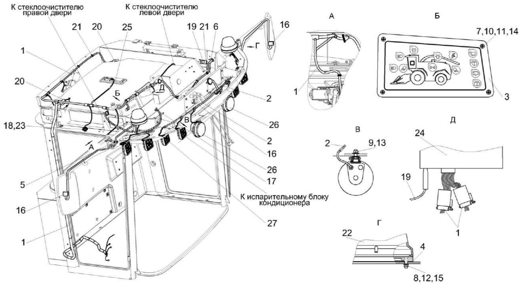
Рисунок 260 – Установка электрооборудования кабины КВК-650-11-0722000
