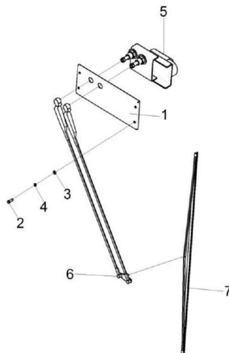
Рисунок 181 – Установка стеклоочистителя УКЗ-01-0101160
