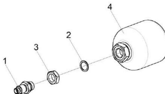
Рисунок 236 – Пневмогидроаккумулятор КВК 0602410
