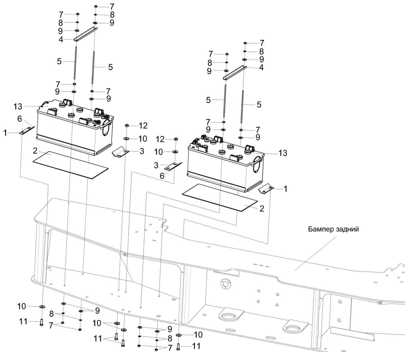
Рисунок 269 – Установка аккумуляторов КВК-650-10-0100400
