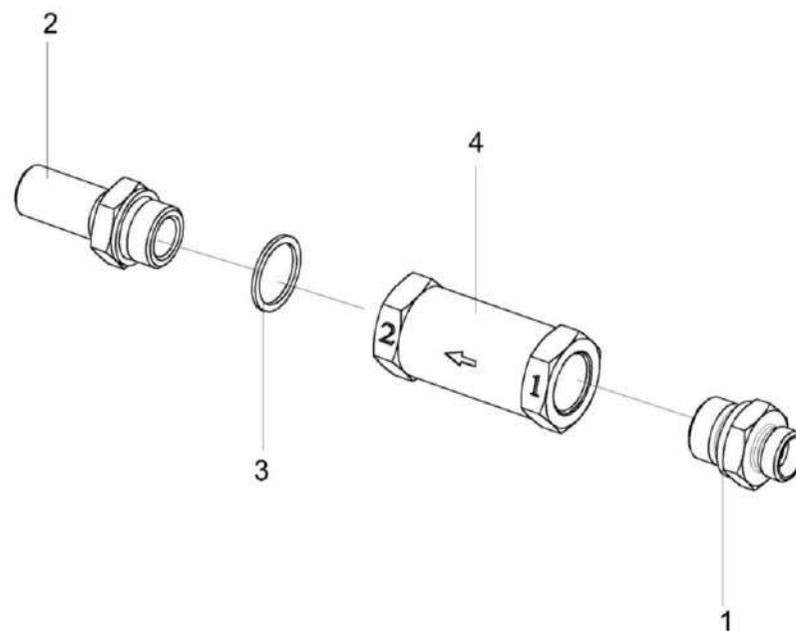
Рисунок 206 – Клапан обратный КВК-6-0801080
