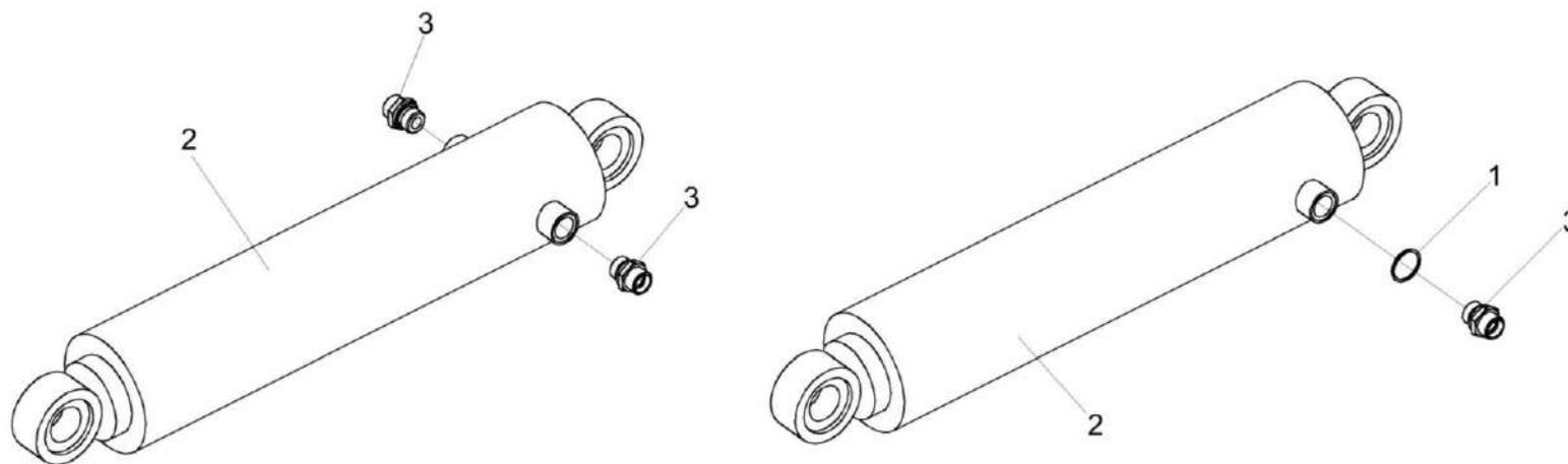
Рисунок 212 – Гидроцилиндр навески КВК 0602500Б и КВК 0602500Б-01
