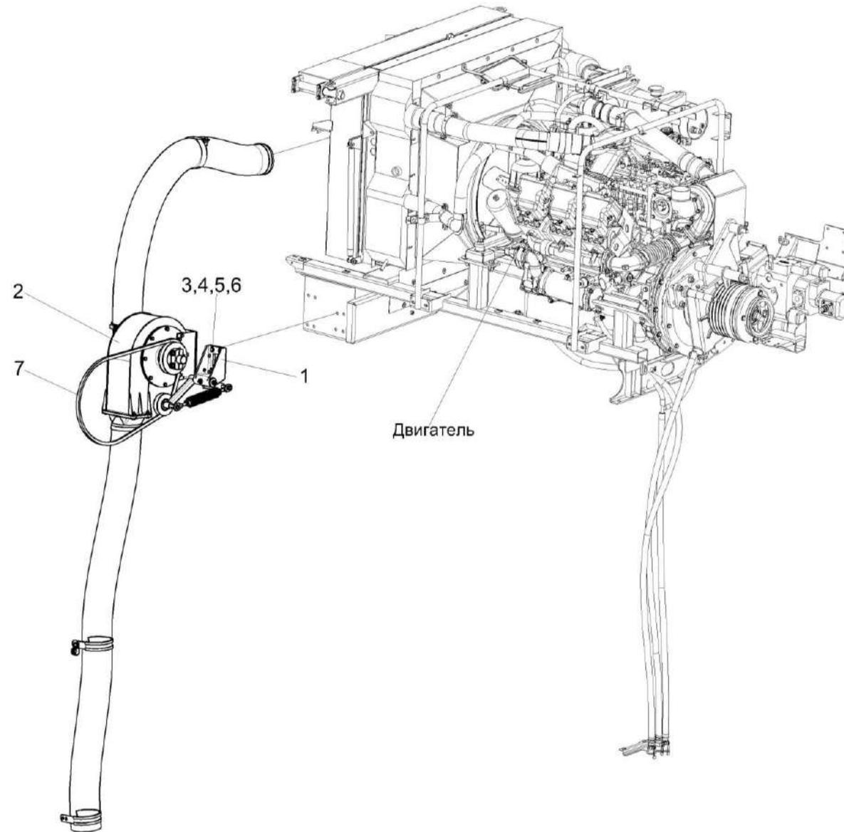
Рисунок 205 – Установка вентилятора КЗК-12-23-0106210
