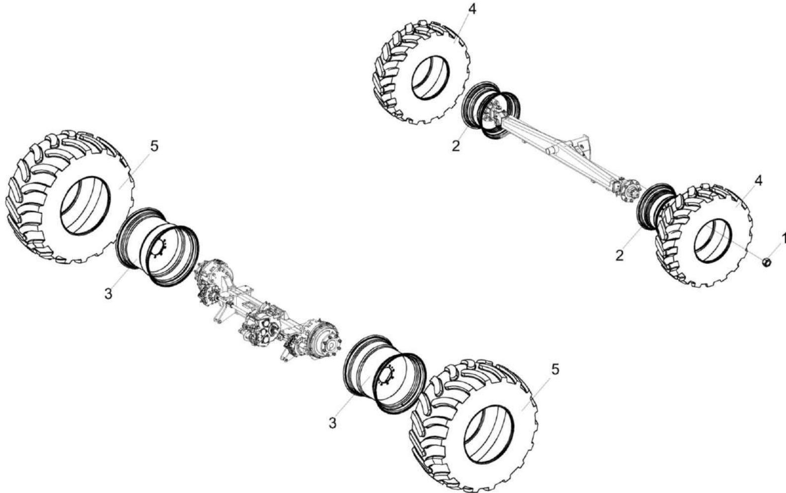
Рисунок 70 – Установка колес КЗК-12-0111100
