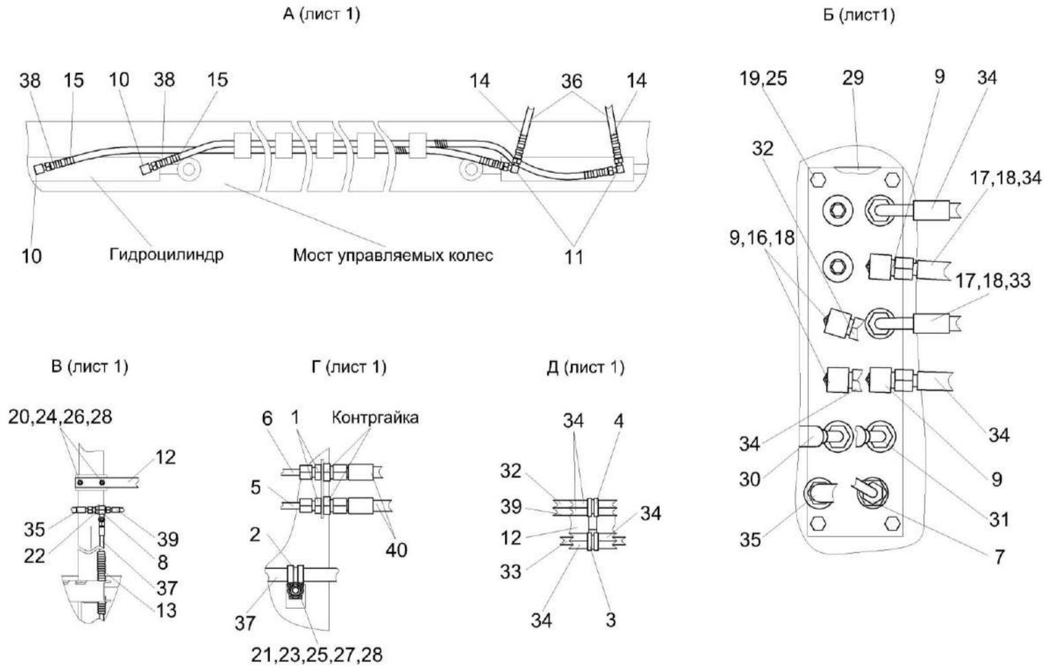
Рисунок 264 – Гидросистема рабочих органов и рулевого управления КЗК-12-22-0602000 (лист 2)
