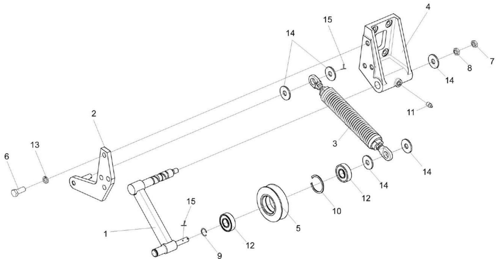
Рисунок 208 – Устройство натяжное КЗК-10-0112010
