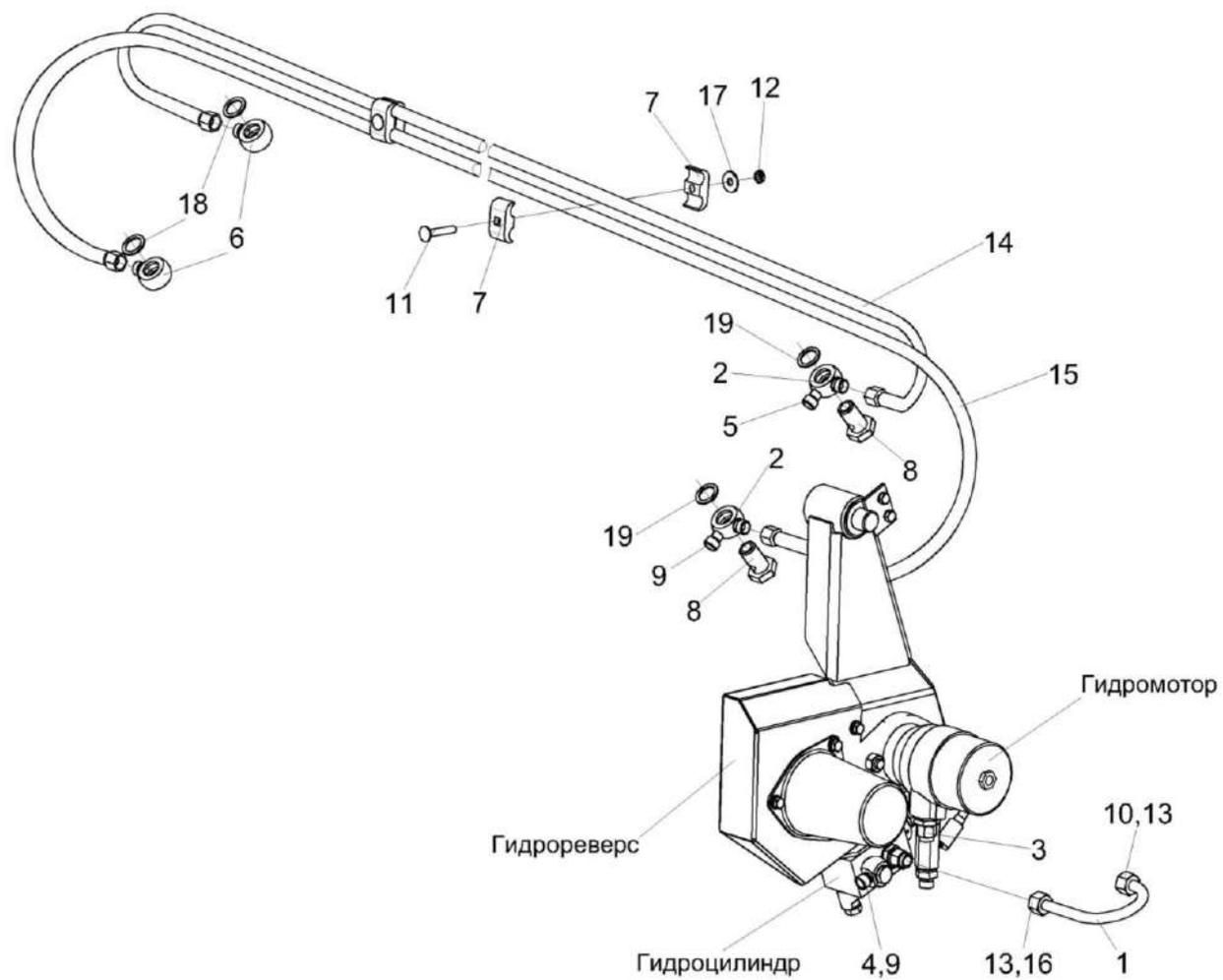
Рисунок 28 – Система гидравлическая камеры наклонной КЗК-12-1790000А-01
