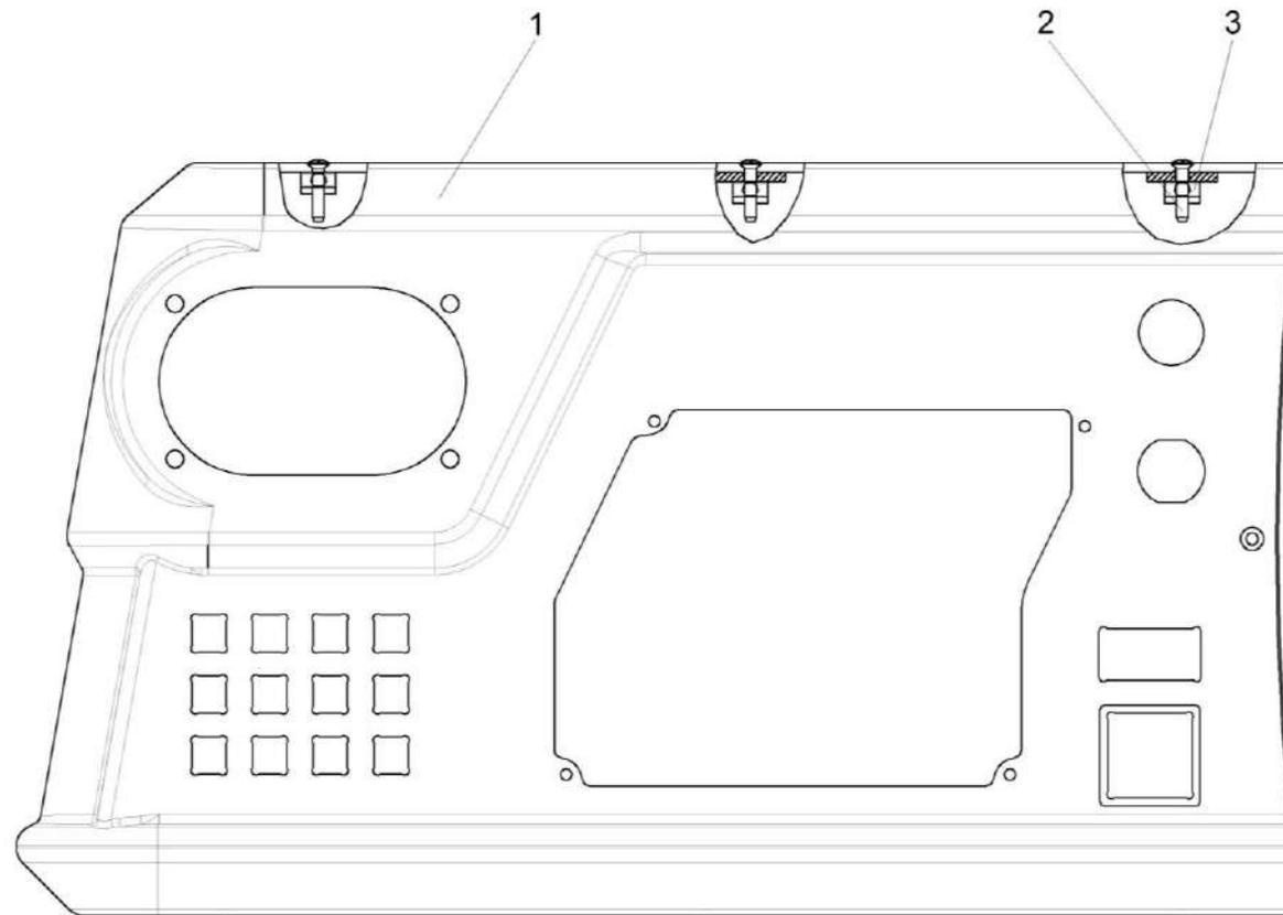
Рисунок 164 – Установка панели КЗК-12-22-0119480
