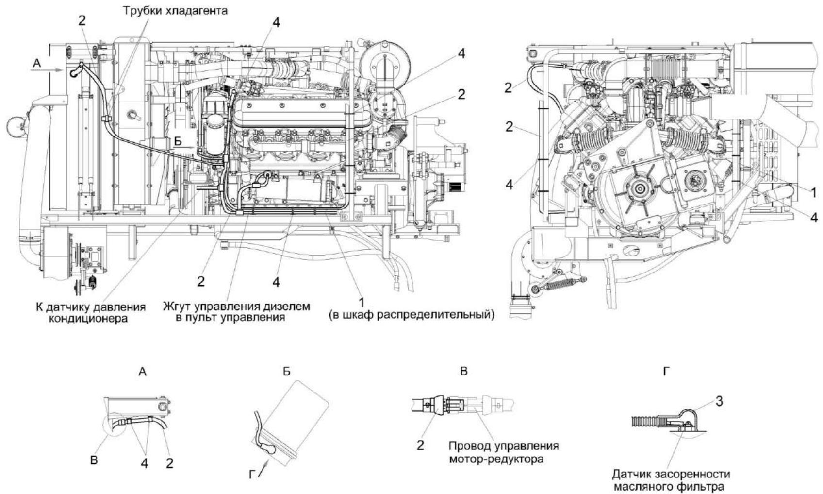
Рисунок 202 – Установка электрооборудования моторной установки КЗК-12-23-0726000 (лист 1)
