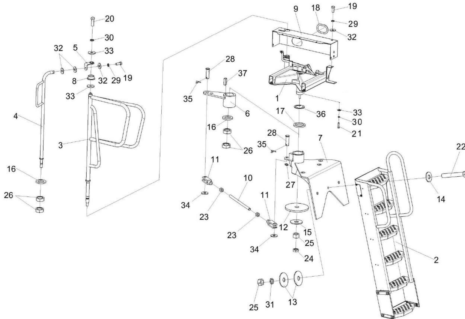
Рисунок 236 – Установка трапа КЗК-12-0117000А
