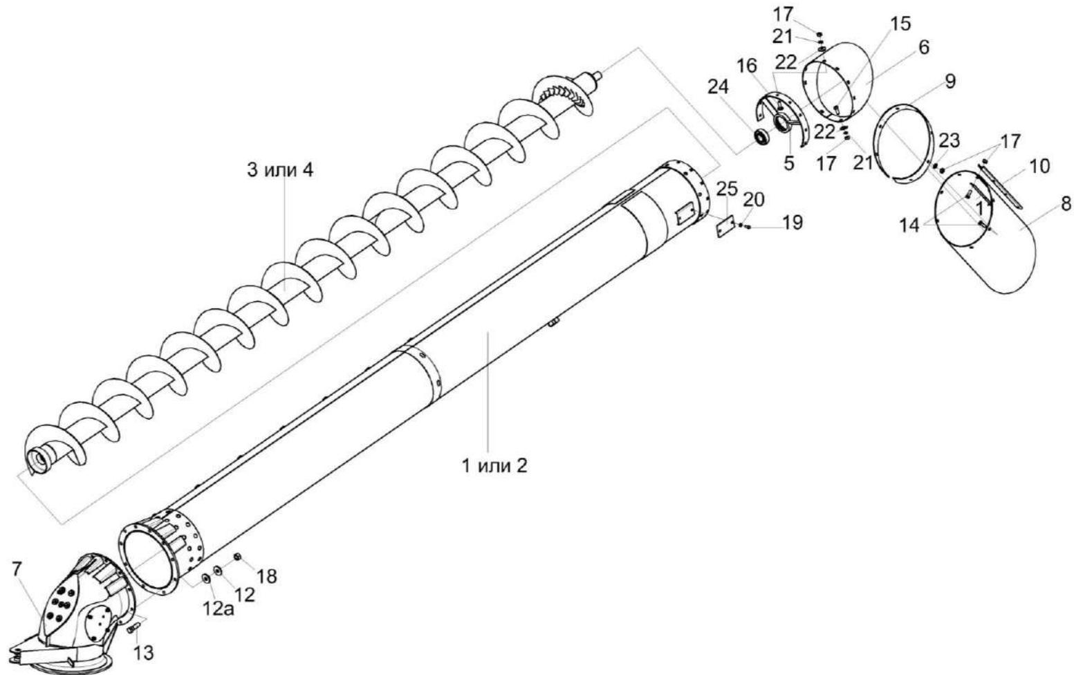
Рисунок 111 – Шнек с отводом КЗК-3219-0206000А и КЗК-3219-0206000А-01
