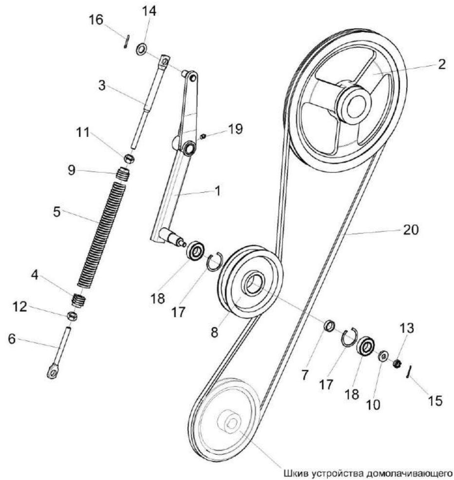
Рисунок 25 – Установка привода устройства домолачивающего
