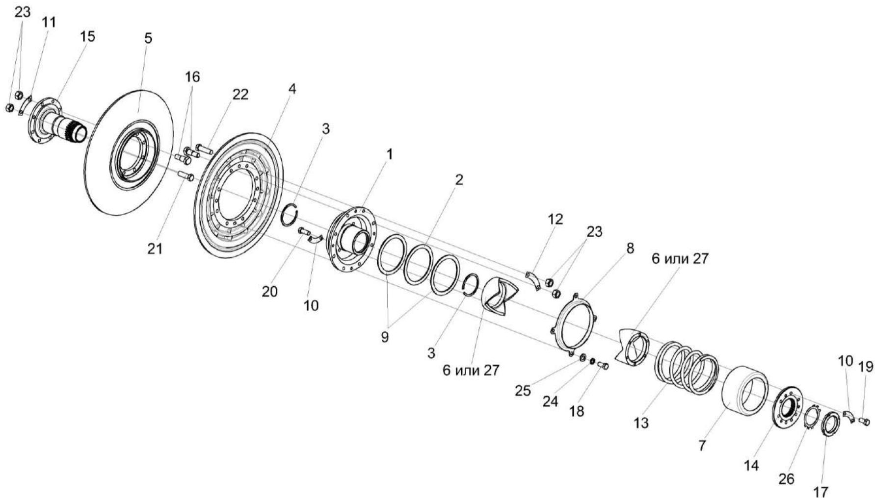
Рисунок 39 – Вариатор барабана КЗК 0123000 и КЗК 0123300
