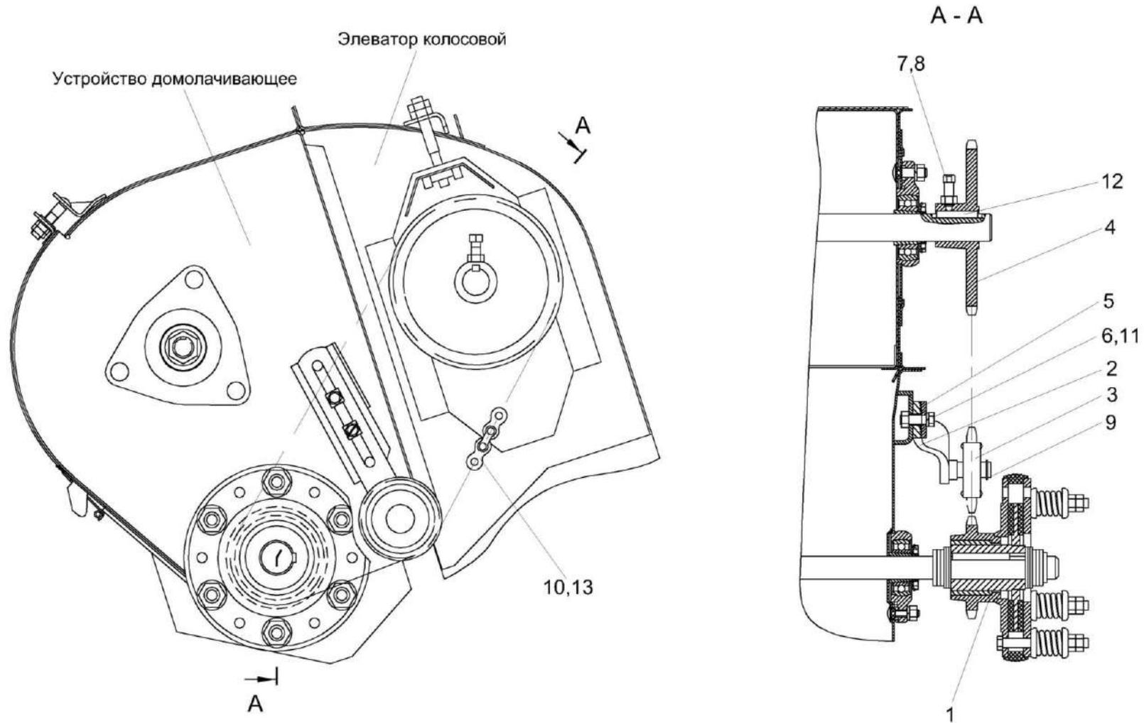
Рисунок 9 – Установка цепного привода элеватора колосового
