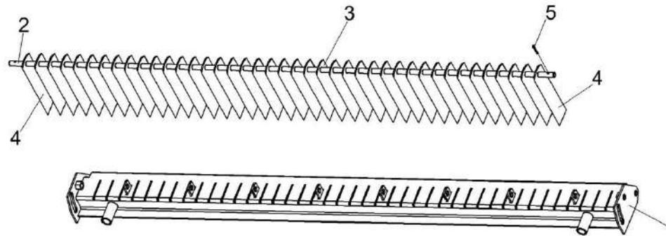
Рисунок 130 – Опора ножевая КЗК-3219-0290030
