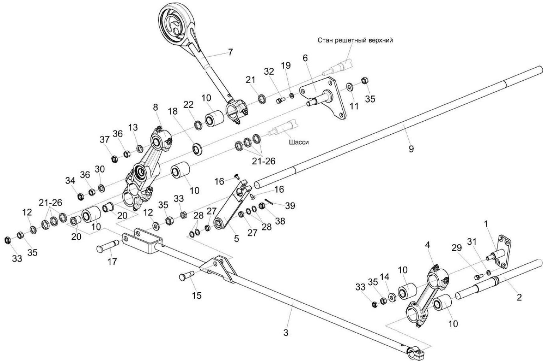
Рисунок 15 – Установка привода доски стрясной КЗК-12-0280200 (вид справа)
