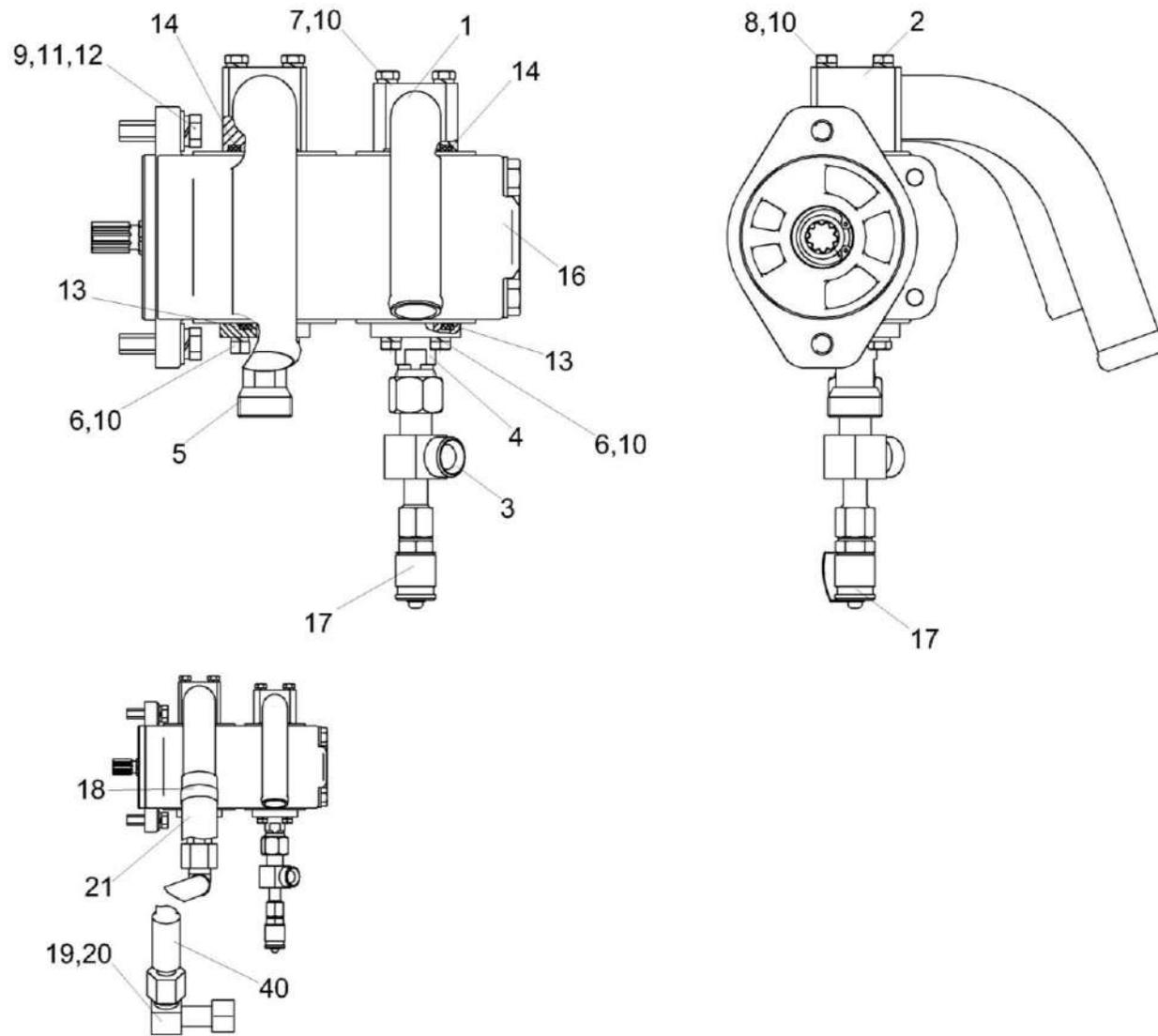
Рисунок 283 – Гидронасос двухсекционный КЗК-12-19-0602100-01
