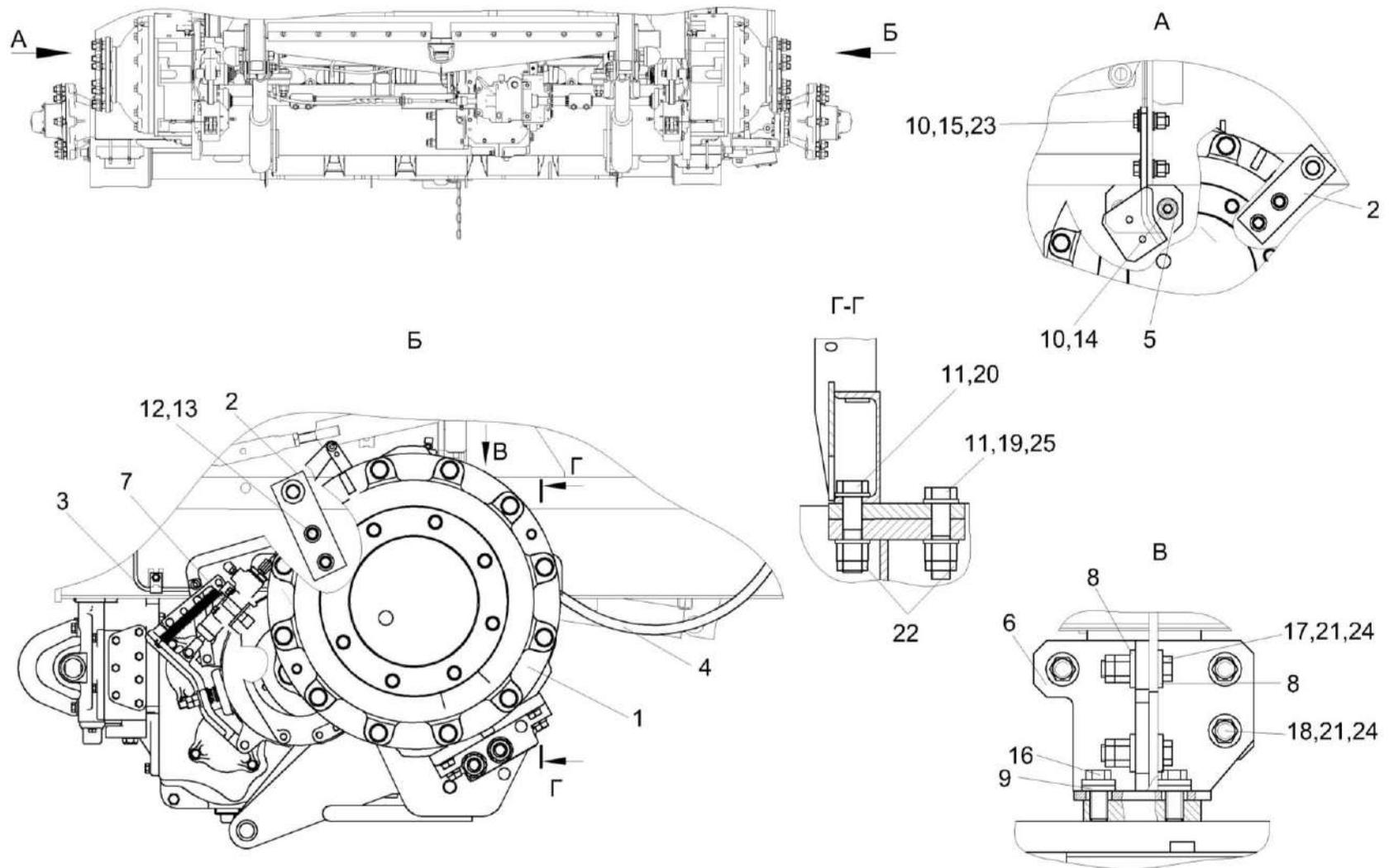
Рисунок 71 - Установка моста ведущего КЗК-12-22-0111300-01
