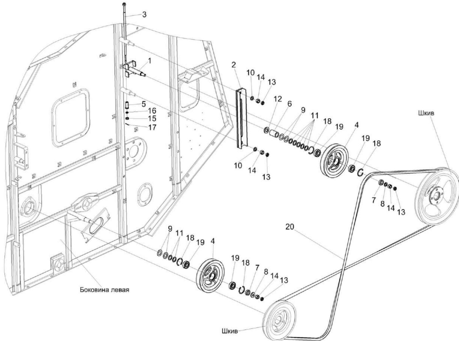
Рисунок 12 – Установка привода солоотряса
