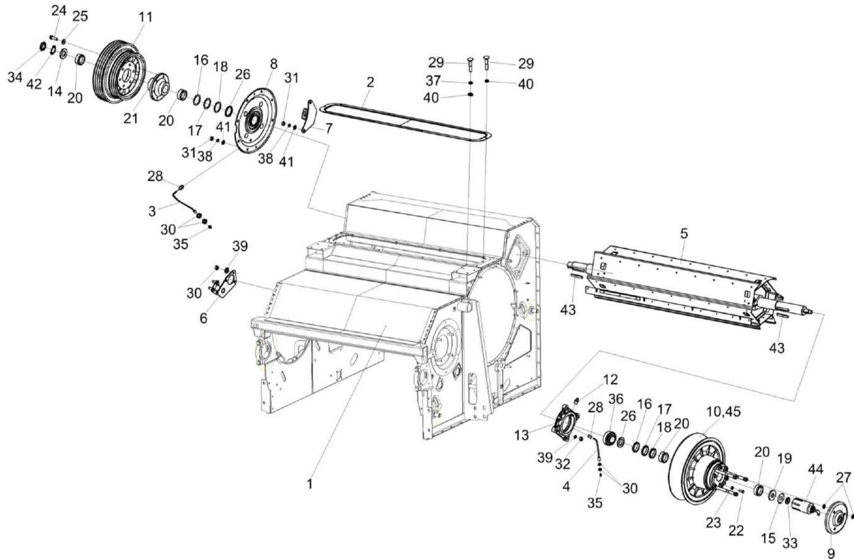
Рисунок 27 – Аппарат молотильный КЗК-12-22-1-0102000 (установка битера отбойного)
