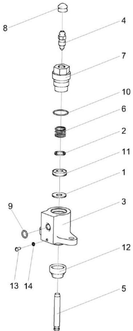
Рисунок 85 – Гидроцилиндр КЗК-12-0107200-01
