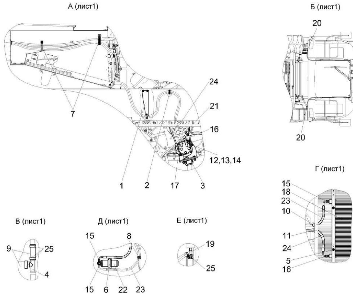
Рисунок 168 – Установка оборудования кондиционера КЗК-12-22-0113010 (лист 2)
