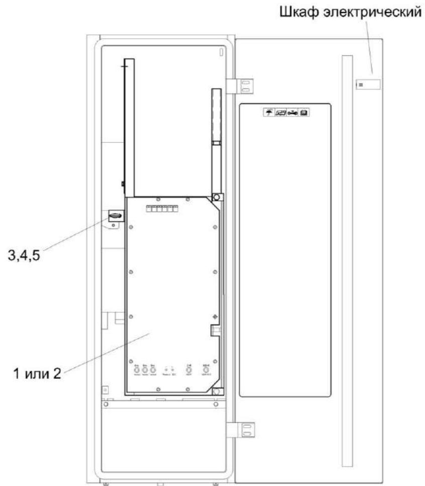
Рисунок 293 – Установка шкафа электрического КЗК-3219-0722020 и КЗК-3219-0722080
