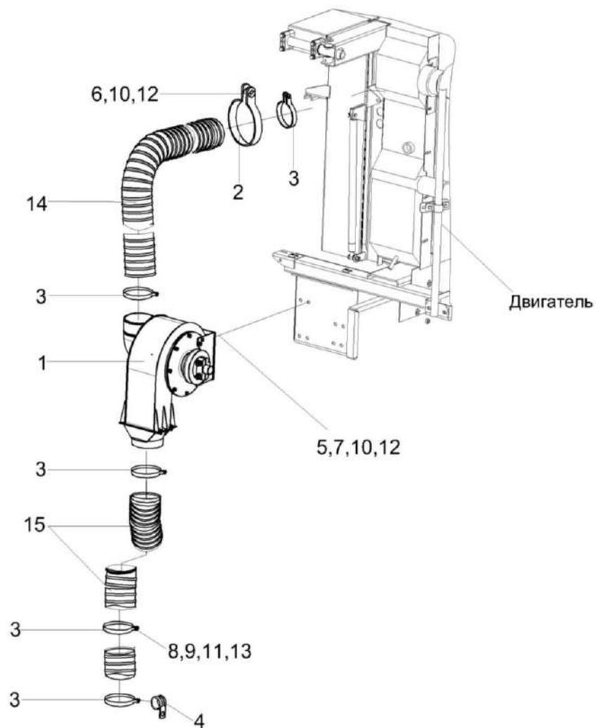
Рисунок 206 – Установка вентилятора КЗК-12-3-0112240
