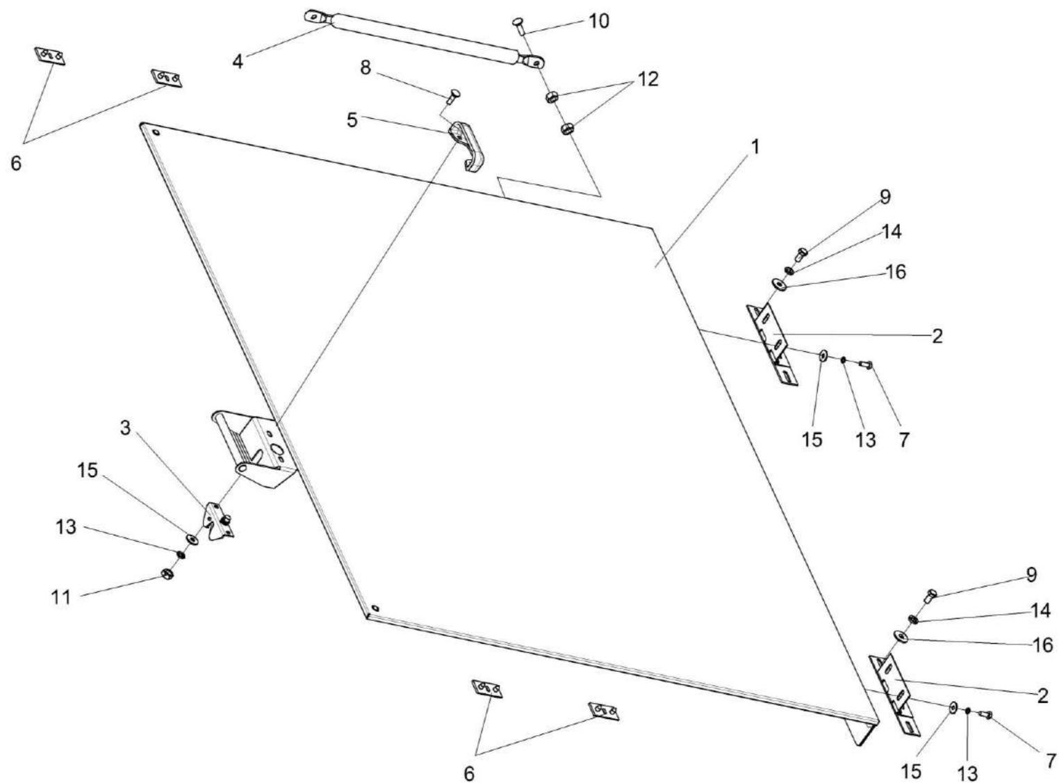
Рисунок 248 – Установка крыши КЗК-12-0124000А
