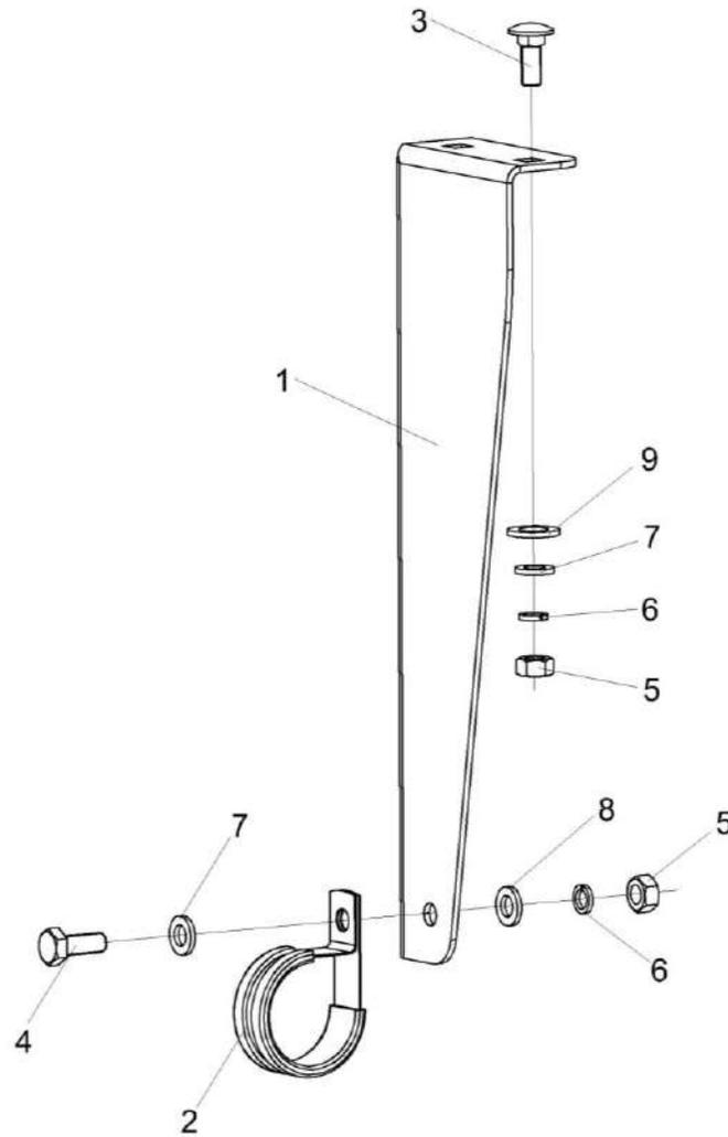
Рисунок 169 Установка кронштейна КЗК-12-0113190
