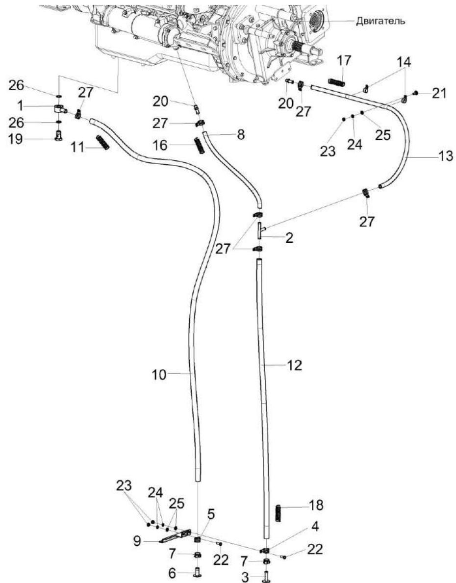
Рисунок 200 – Установка сливных рукавов КЗК-12-3-0106490
