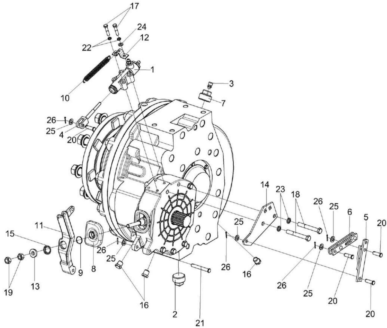
Рисунок 73 – Редуктор бортовой КЗК-10-0107200 (лист 1)
