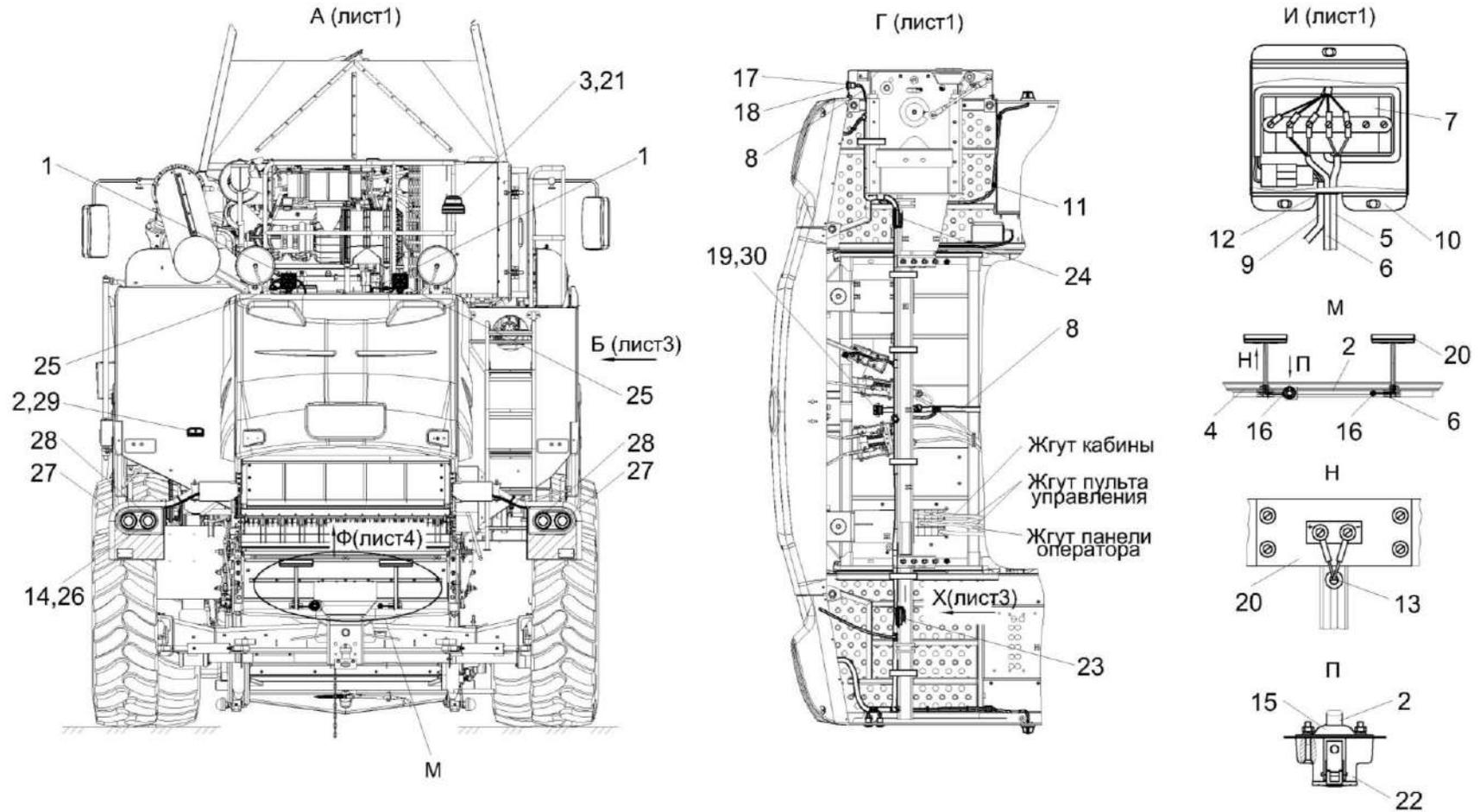
Рисунок 288 - Установка электрооборудования молотилки КЗК-12-23-0721000 (лист 2)
