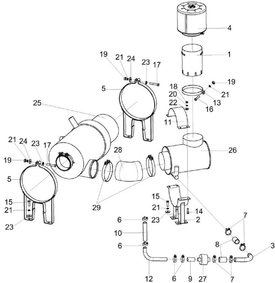
Рисунок 210 – Установка фильтра воздушного КЗК-12-3-0126340А
