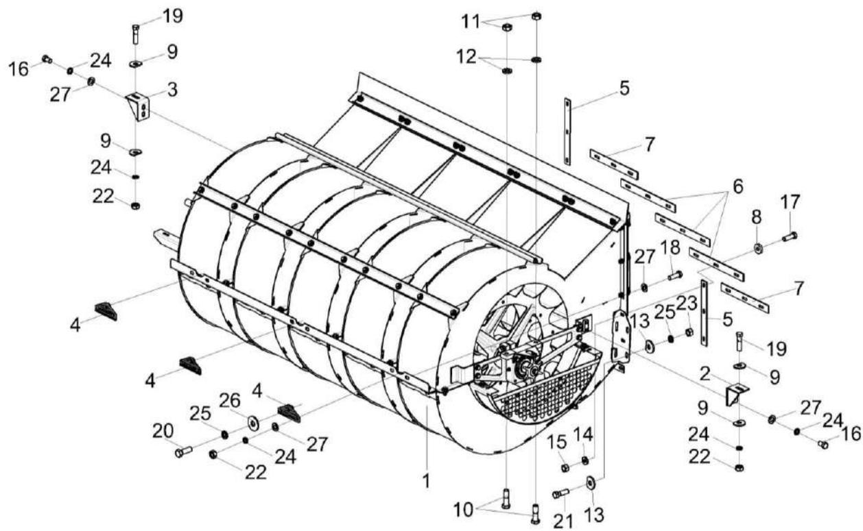
Рисунок 59 – Установка вентилятора КЗК-3219-0217500
