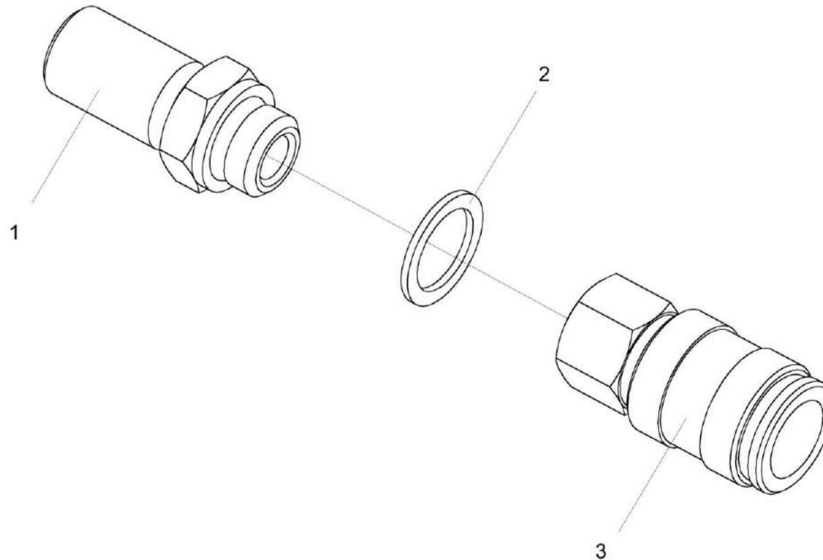
Рисунок 304 – Пневмовывод КНС-6028-0180110
