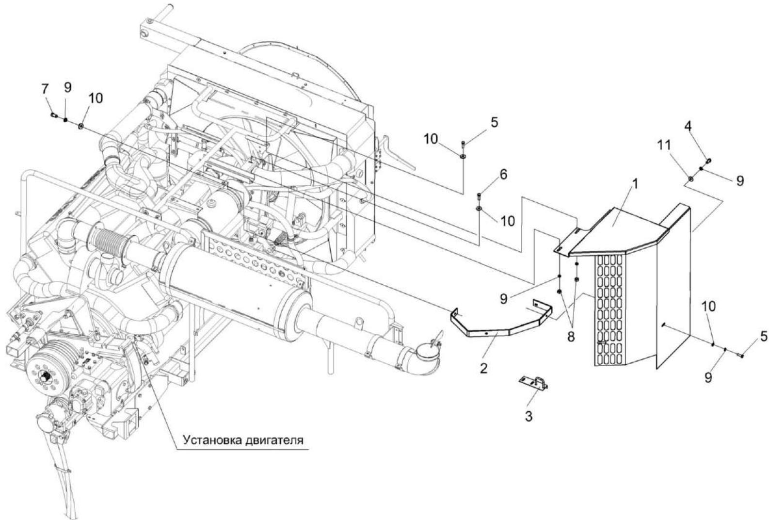
Рисунок 199 – Установка ограждения КЗК-12-3-0106330Г-01
