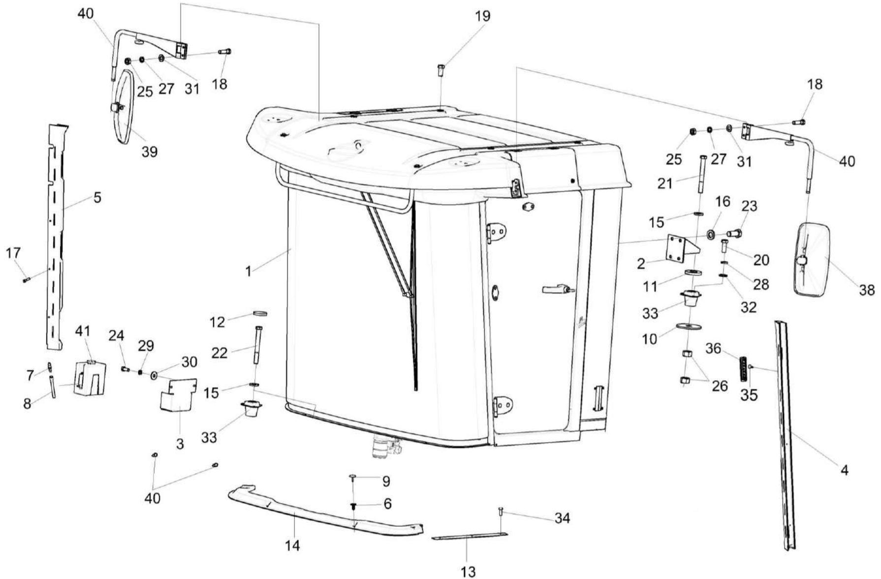
Рисунок 138 – Установка кабины УКЗ-01-0100000
