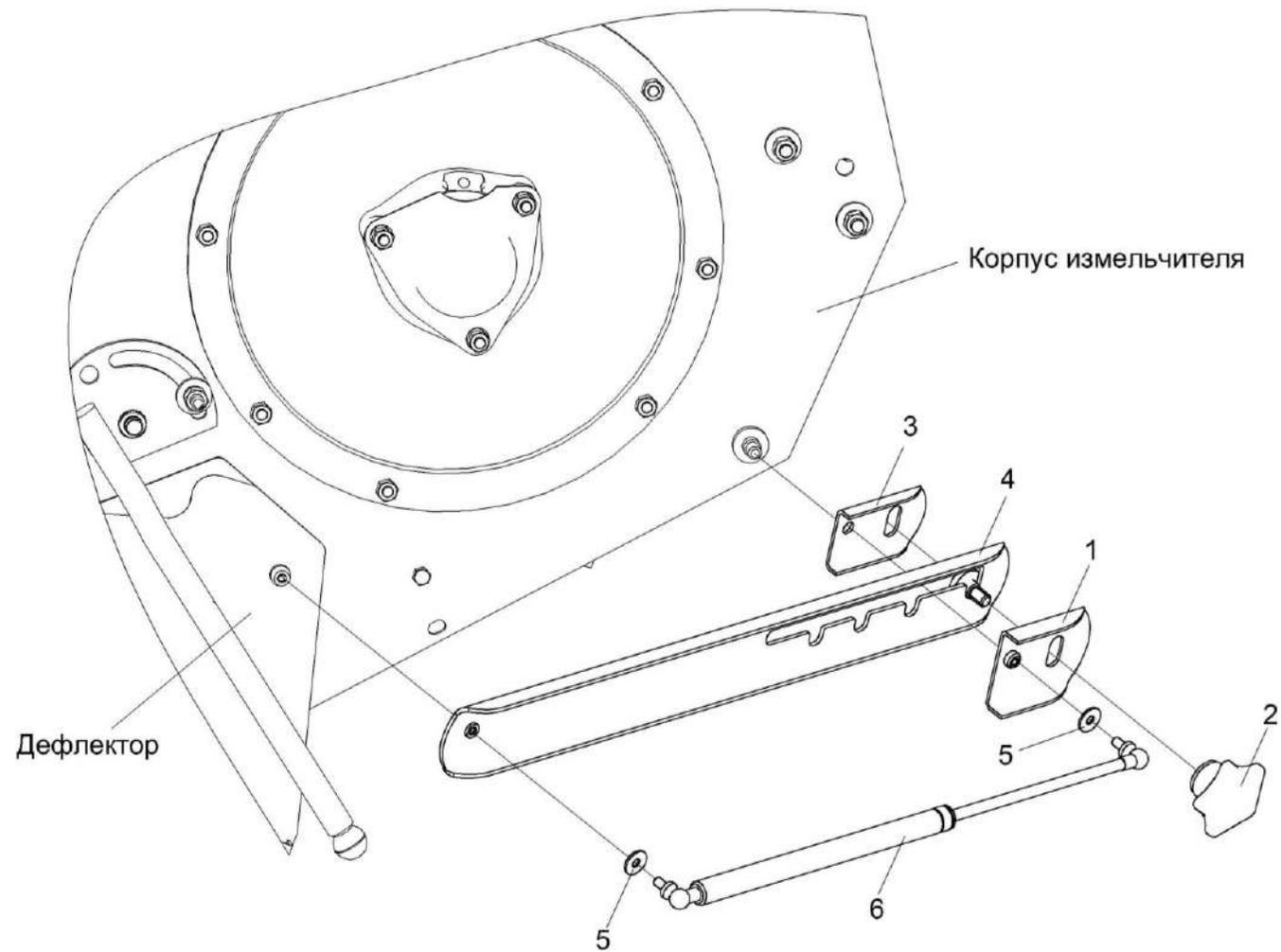
Рисунок 137 – Установка газовых пружин КЗК-3321-0290100 и КЗК-3321-0290100-01
