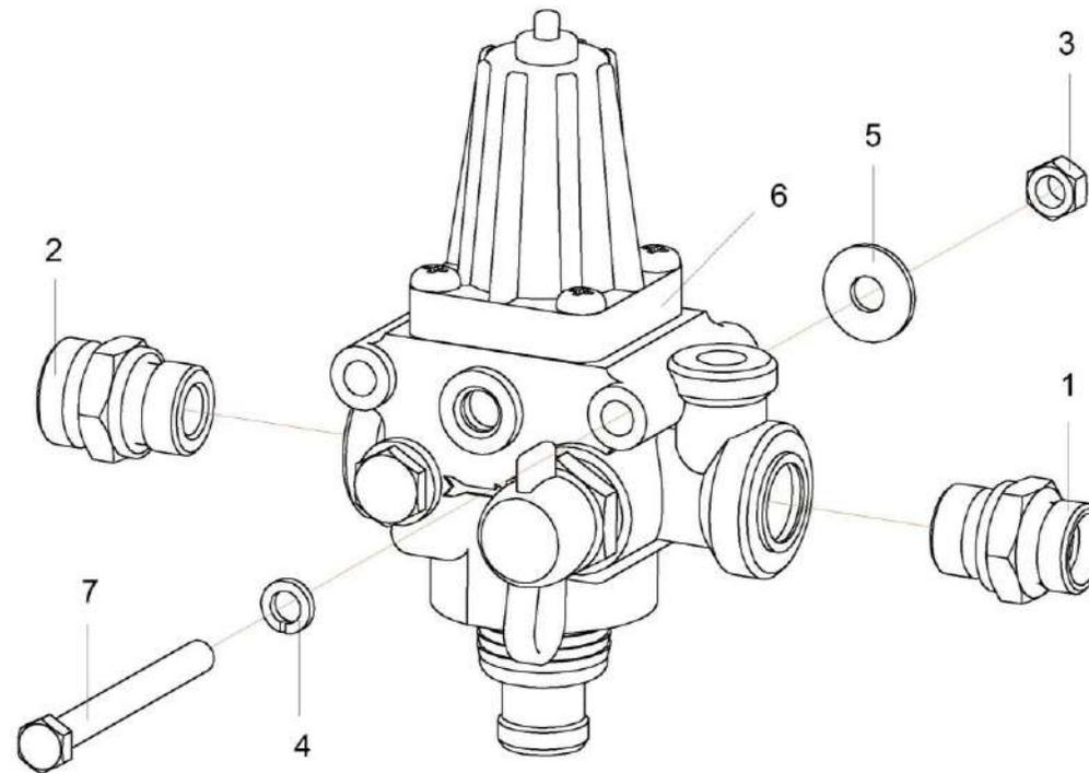
Рисунок 303 – Регулятор давления КНС-6028-0180190
