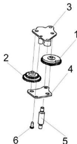
Рисунок 150 – Привод КЗК-13-0119300
