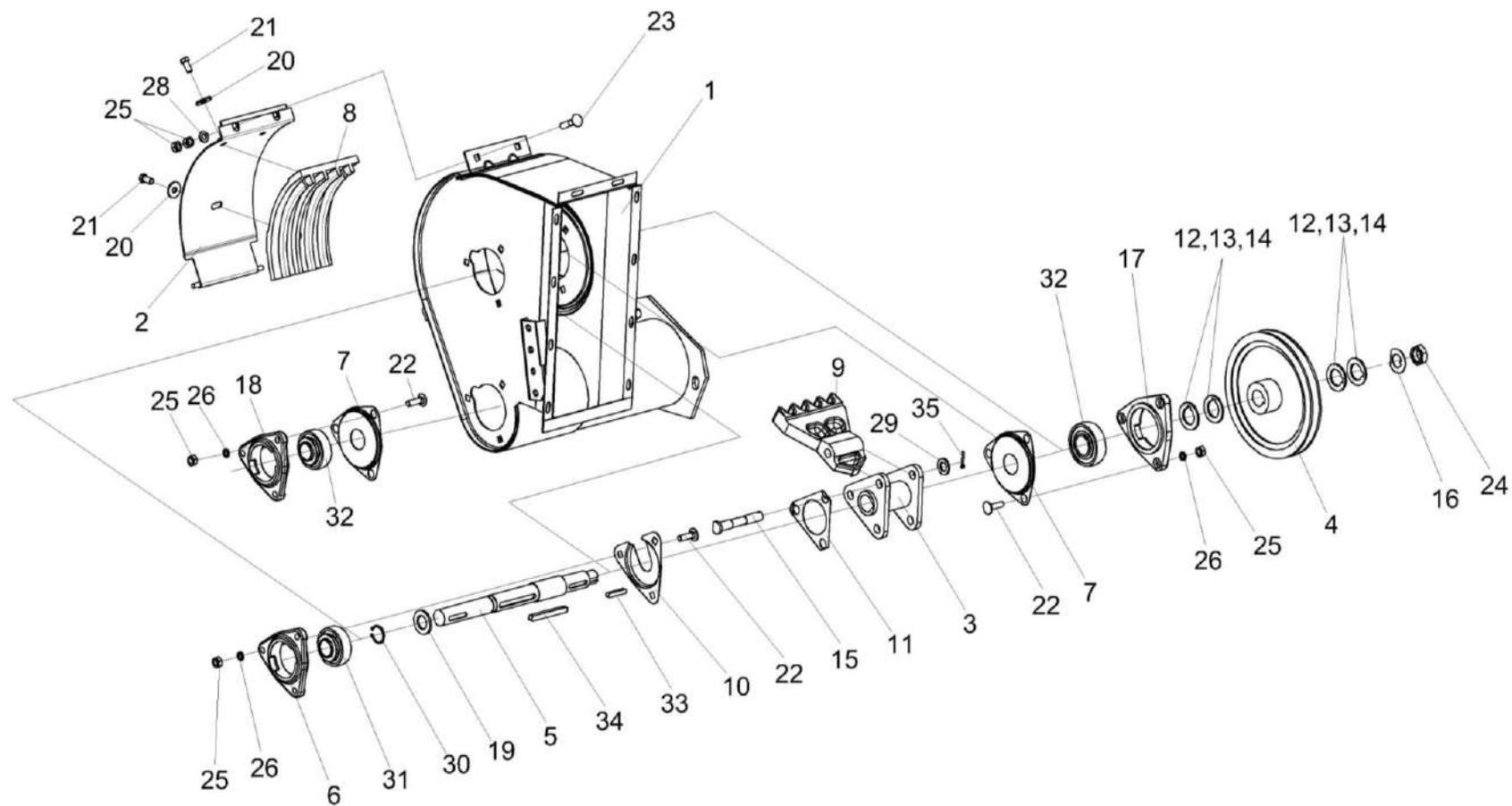
Рисунок 26 – Устройство домолачивающее КЗК 0207000В-01
