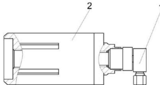
Рисунок 42 – Гидроцилиндр КЗК-10-3-0602500
