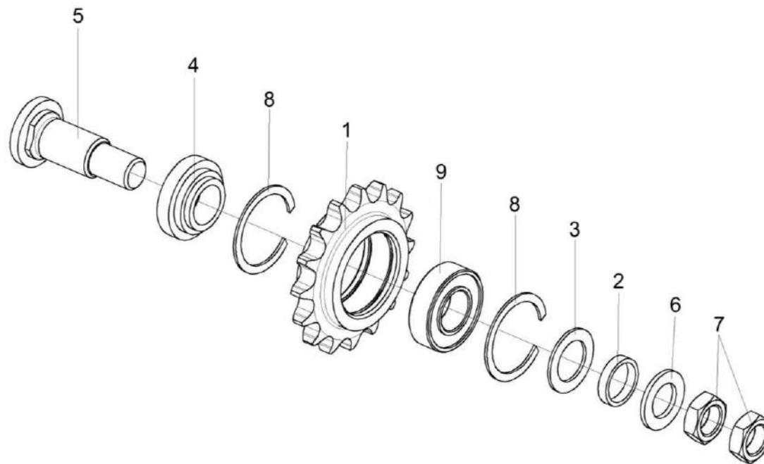
Рисунок 100 – Звездочка КЗР 0219070Б
