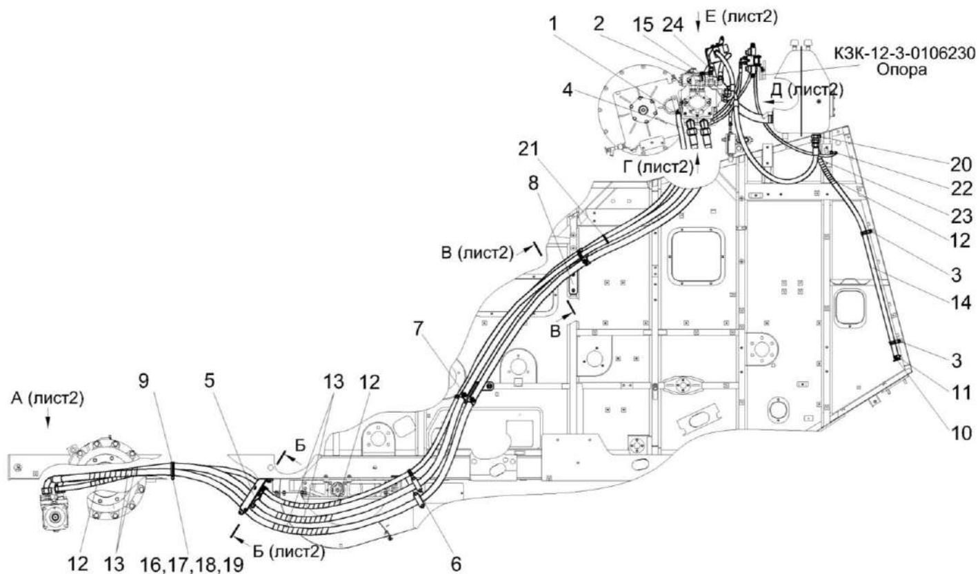
Рисунок 256 – Гидросистема привода ходовой части КЗК-12-22-0601000 (лист 1)
