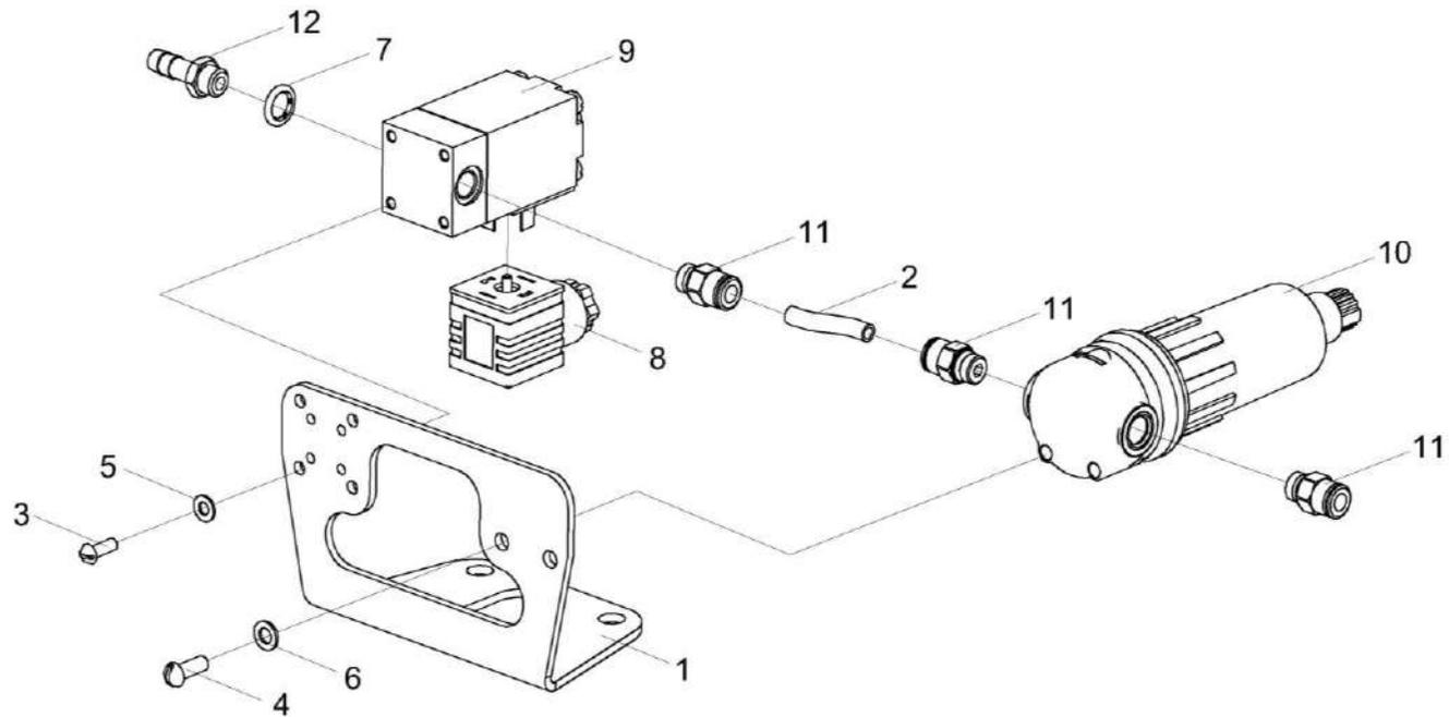
Рисунок 305 – Установка фильтра пневматического КЗК-810-0800300
