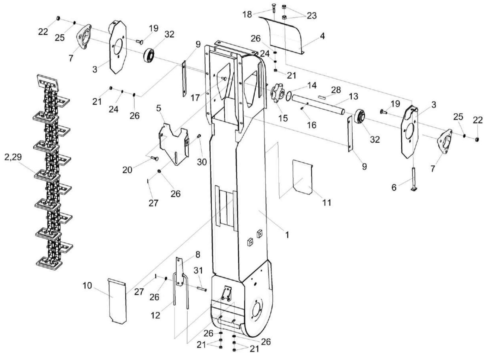
Рисунок 52 – Элеватор колосовой КЗК 0208000Б-04
