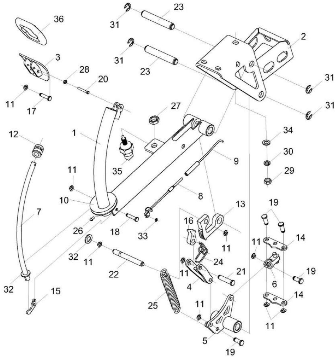
Рисунок 155 – Установка стояночного тормоза УКЗ-01-0261300
