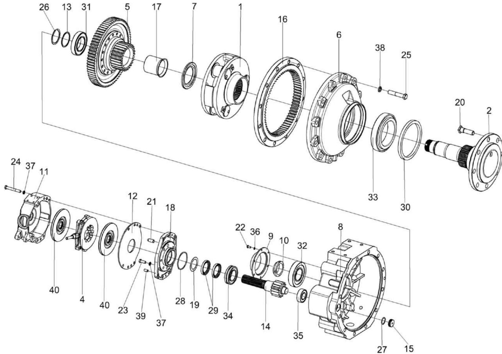
Рисунок 76 – Редуктор бортовой КЗК-10-0107200-04 (лист 2)
