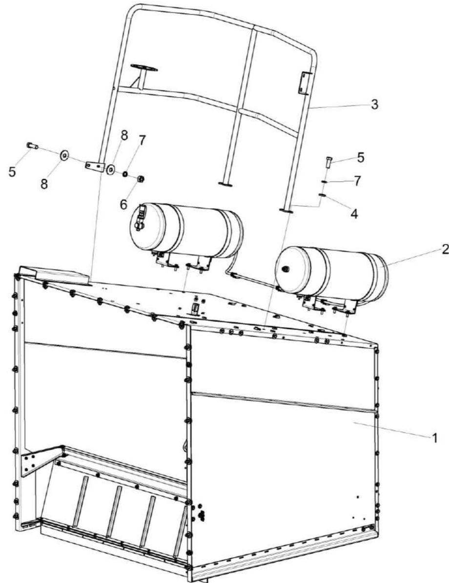
Рисунок 242 – Установка капота КЗК-12-23-0228350
