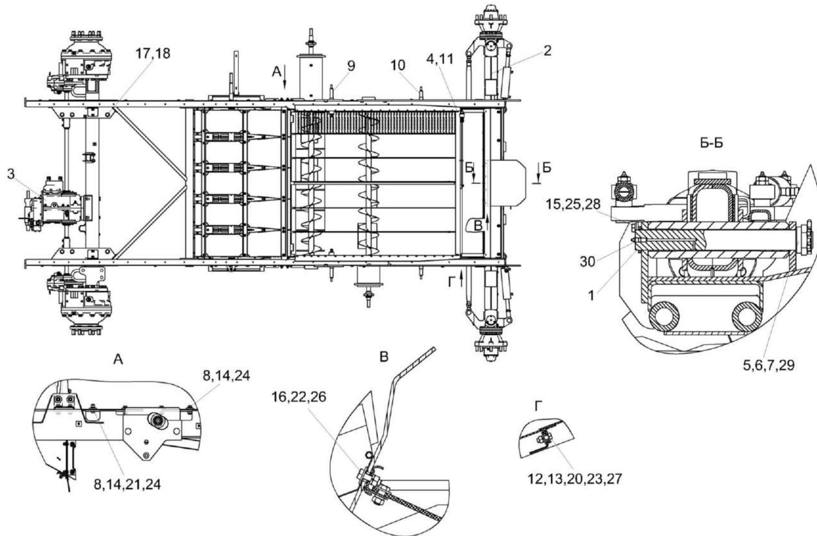
Рисунок 58 – Шасси КЗК-3219-0111000А (вид сверху)
