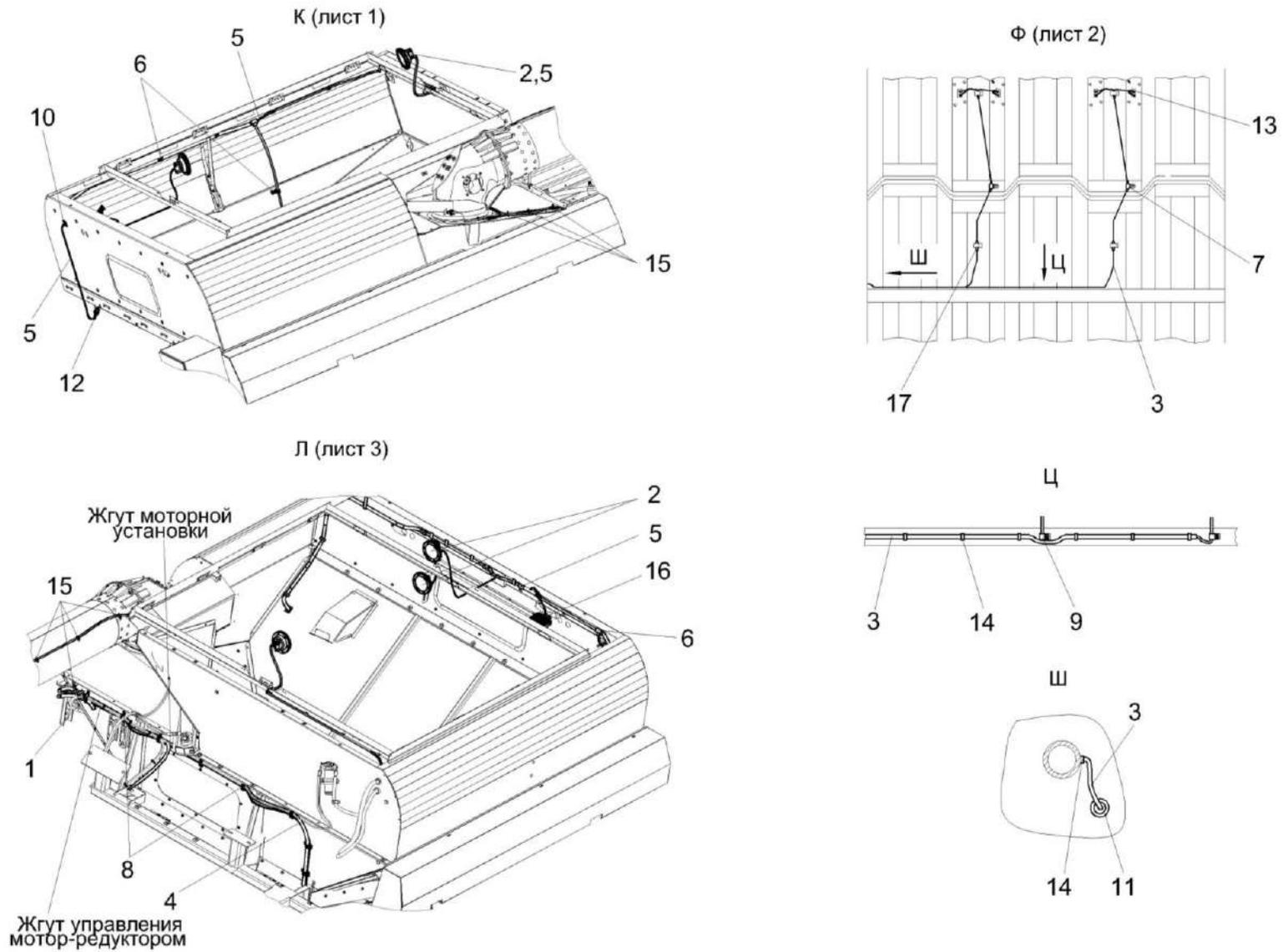
Рисунок 290 - Установка электрооборудования молотилки КЗК-12-23-0721000 (лист 4)
