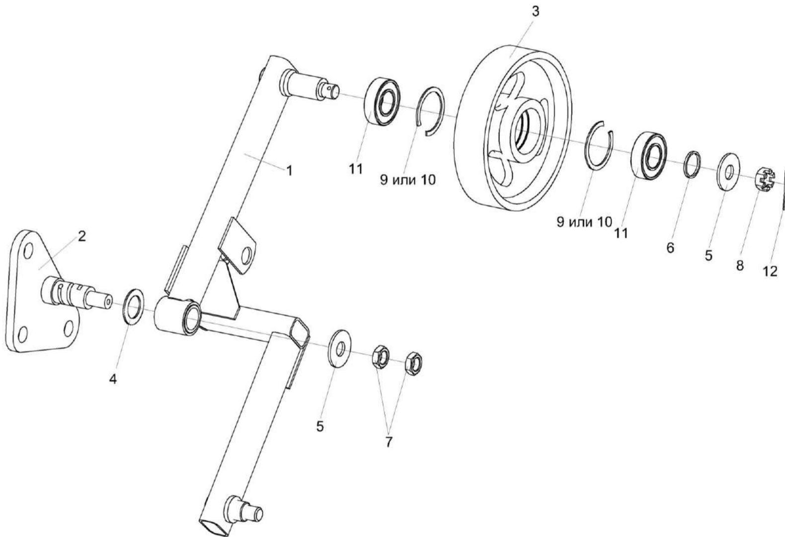
Рисунок 109 – Рычаг КЗК-12А-1-0223010
