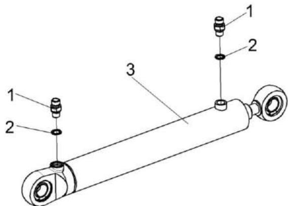
Рисунок 270 – Гидроцилиндр КЗК-10-0602500
