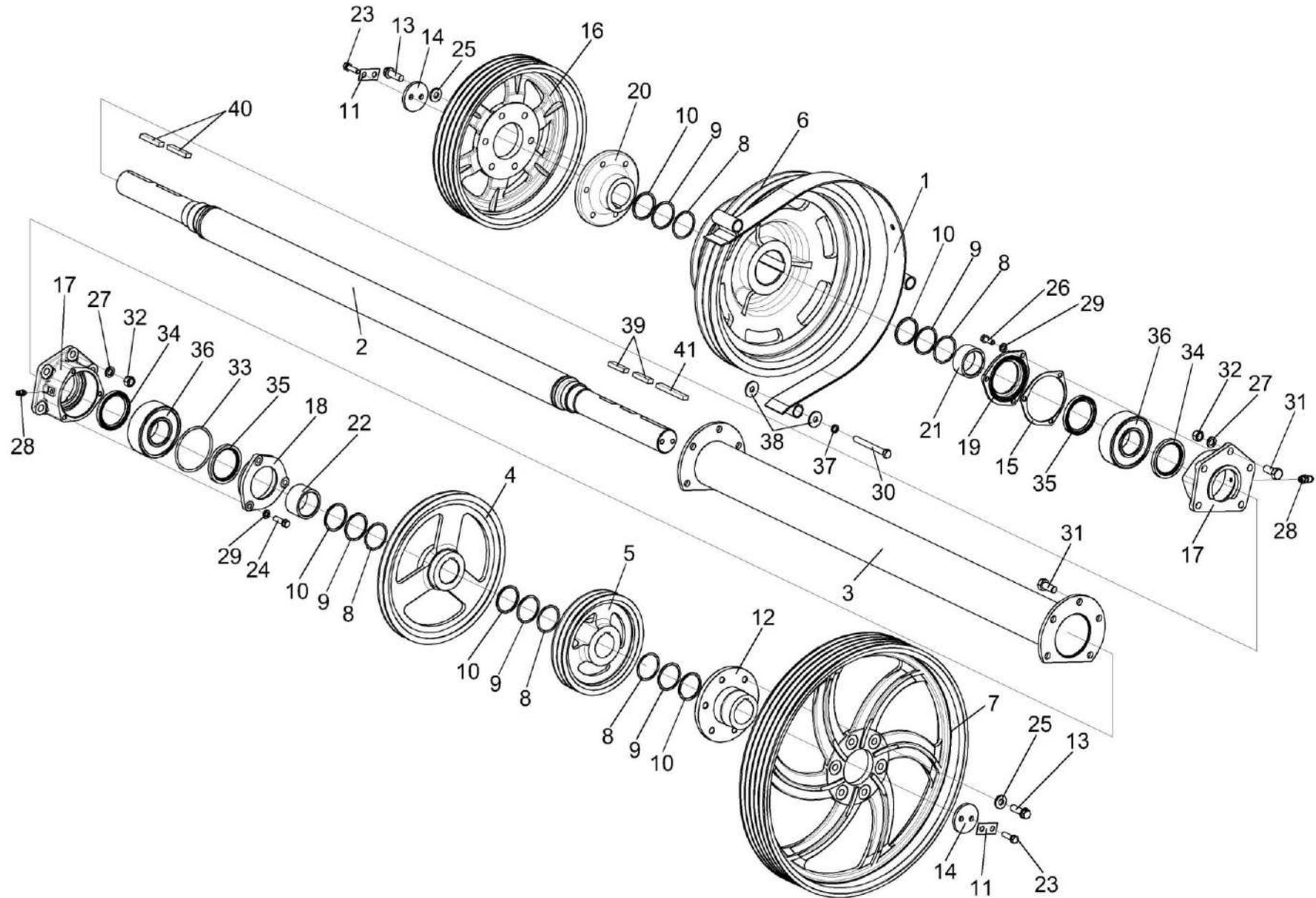
Рисунок 7 – Установка шкивов КЗК-12-0202860А-01 и КЗК-10-0202010-01
