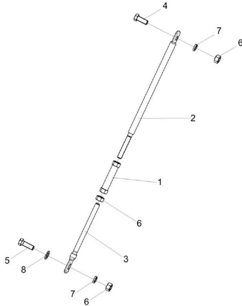
Рисунок 201 – Установка растяжки КЗК-12-3-0126670
