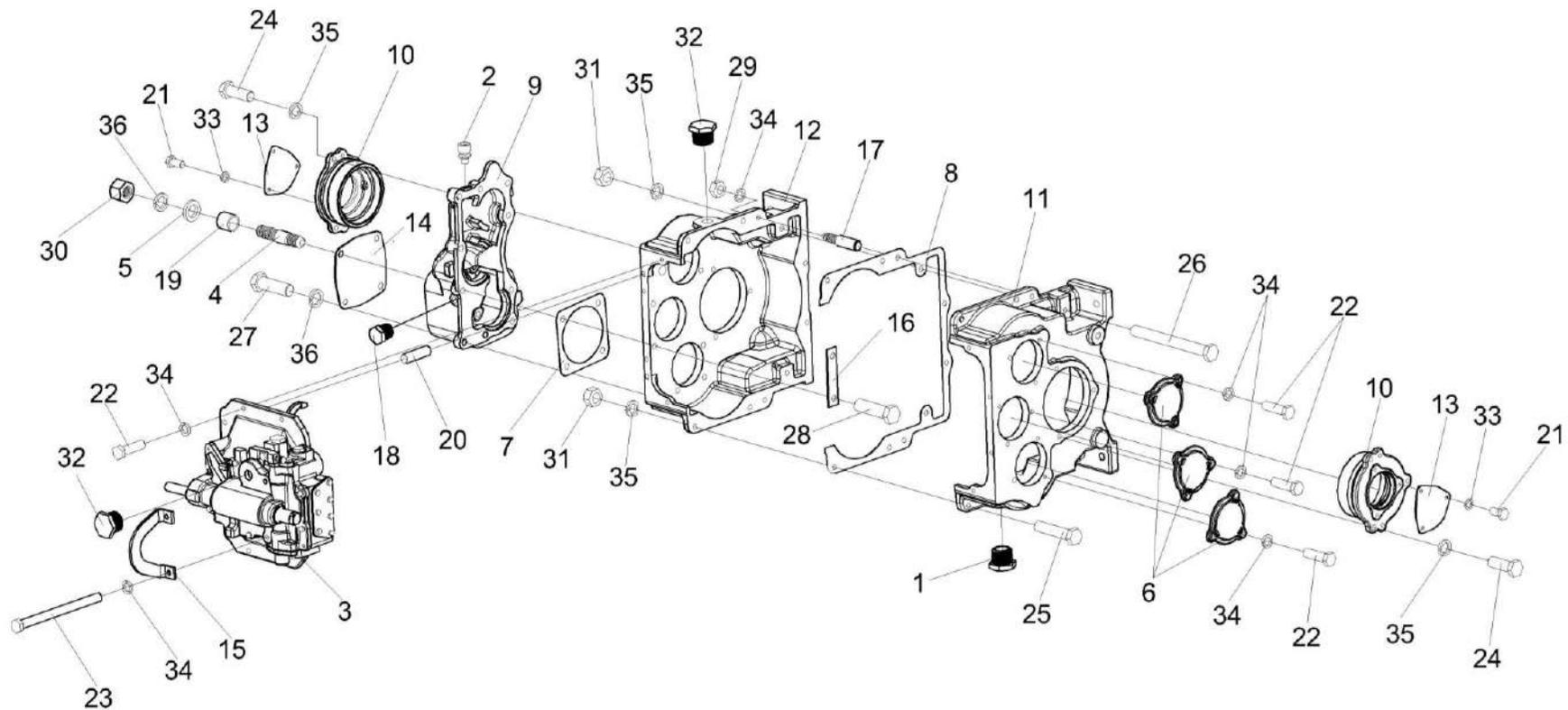
Рисунок 81 – Коробка передач КЗК-12-0107530 (корпус и крышки)
