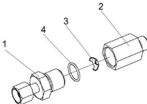
Рисунок 268 – Дроссель с обратным клапаном КЗК 0602520А и КЗК 0602520А-01
