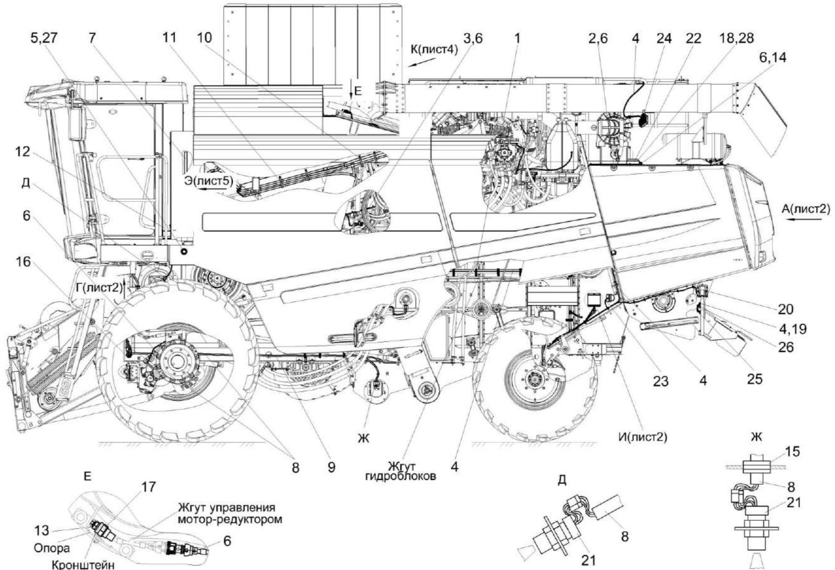
Рисунок 287 - Установка электрооборудования молотилки КЗК-12-23-0721000 (лист 1)
