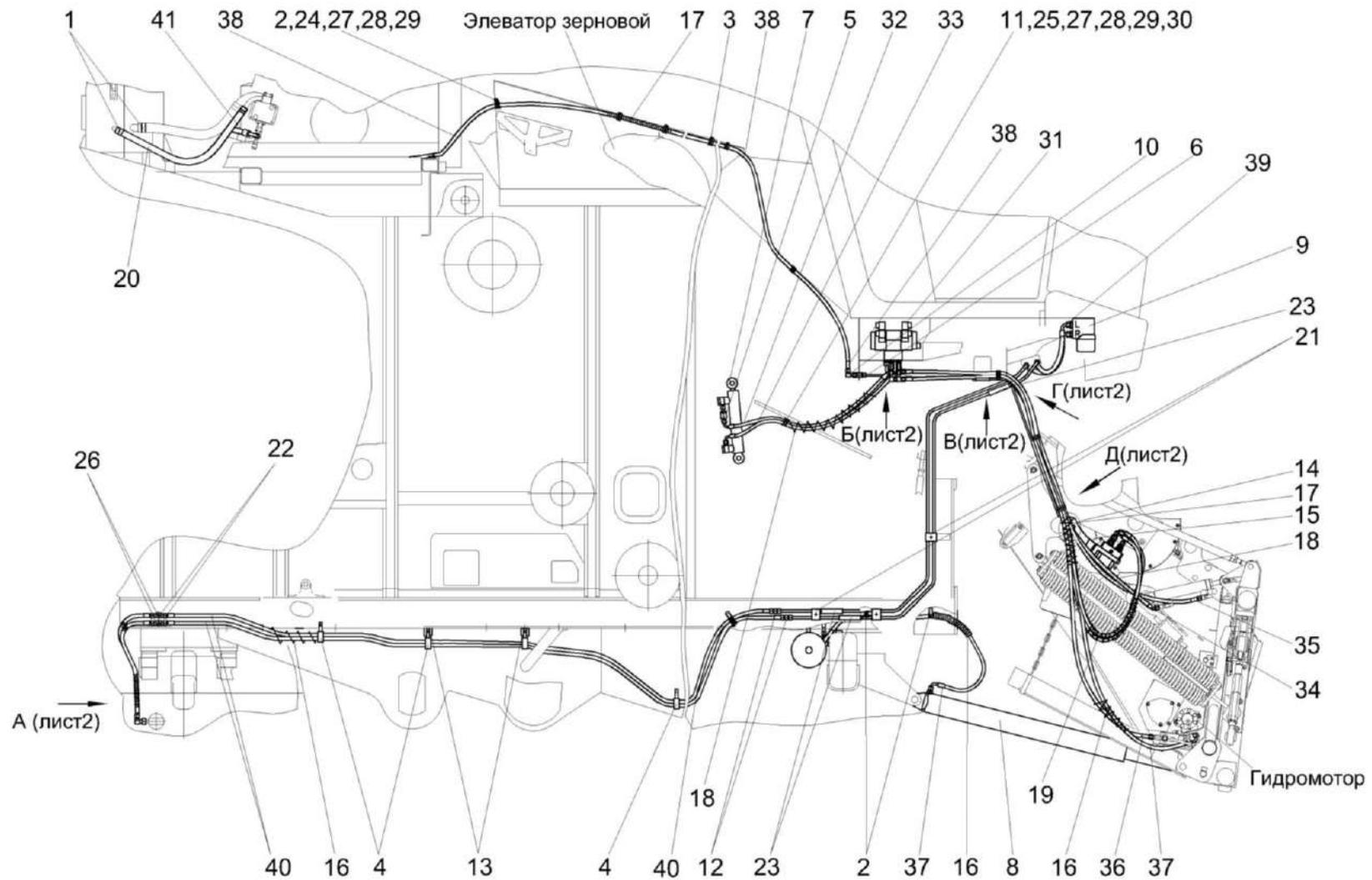
Рисунок 263 – Гидросистема рабочих органов и рулевого управления КЗК-12-22-0602000 (лист 1)
