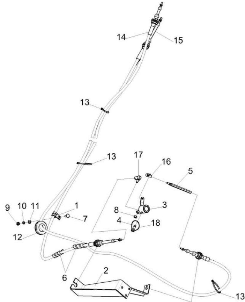
Рисунок 177 – Установка механизма переключения передач КЗК-12-22-0119650
