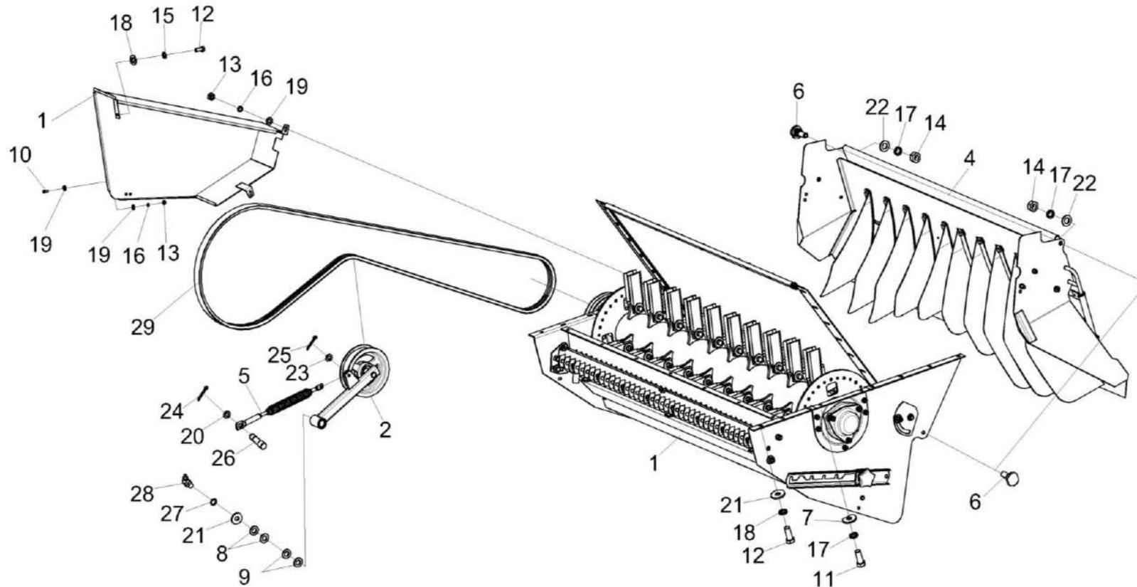
Рисунок 125 – Установка соломоизмельчителя КЗК-12-0290600А (лист 1)
