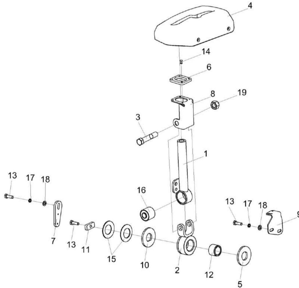
Рисунок 156 – Установка привода ГСТ УКЗ-01-0205110
