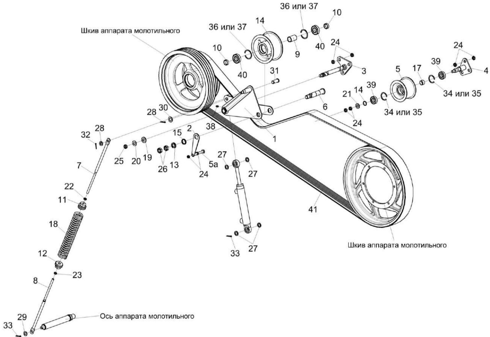
Рисунок 307 – Привод наклонной камеры КЗК-12-16-0125000 (лист 2)
