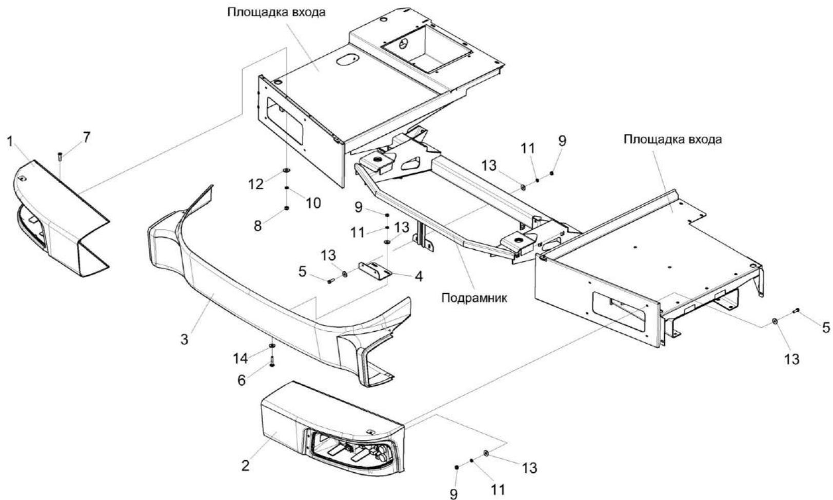
Рисунок 240 – Установка бампера КЗК-3321-1-0132000
