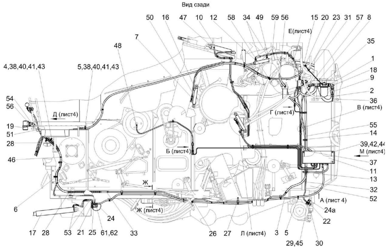
Рисунок 265 – Гидросистема рабочих органов и рулевого управления КЗК-12-22-0602000 (лист 3)
