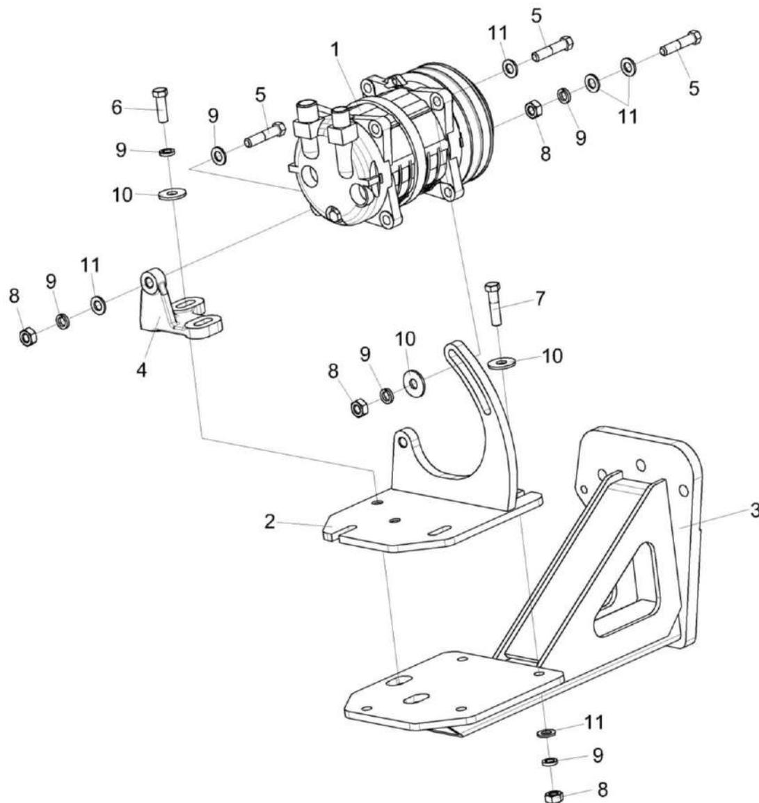
Рисунок 170 – Установка компрессора КЗК-12-0113300
