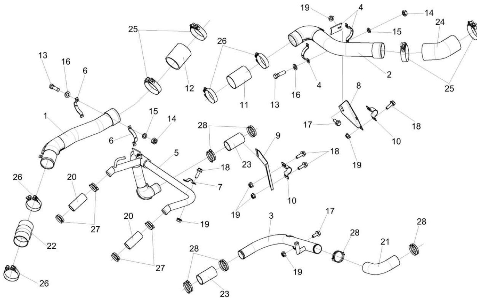
Рисунок 197 – Установка труб КЗК-12-23-0106200
