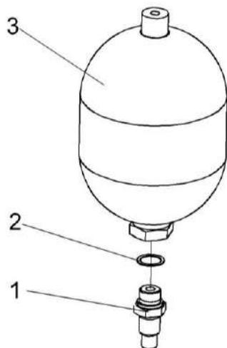
Рисунок 281 – Пневмогидроаккумулятор УЭС-7-0602470
