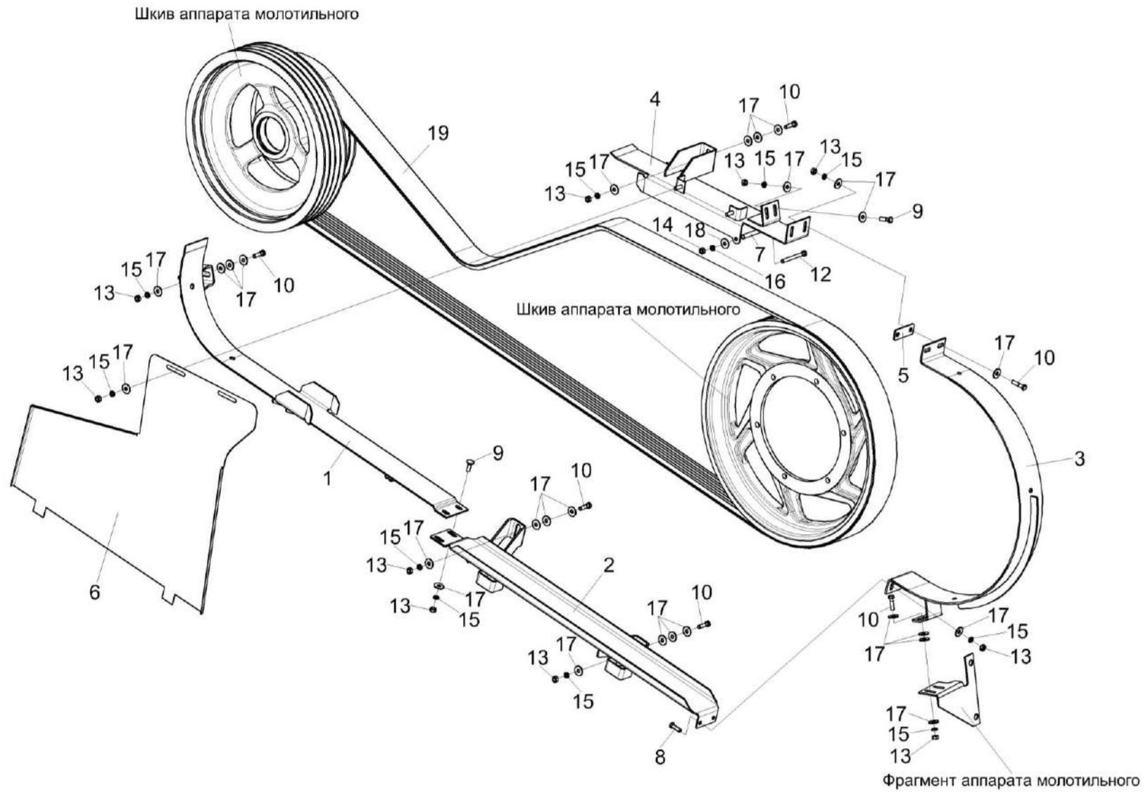
Рисунок 306 – Привод наклонной камеры КЗК-12-16-0125000 (лист 1)
