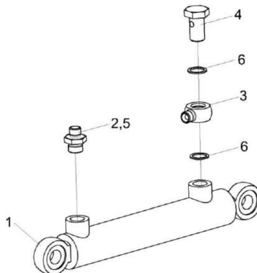
Рисунок 272 – Гидроцилиндр КЗК-10-1-0602510-02
