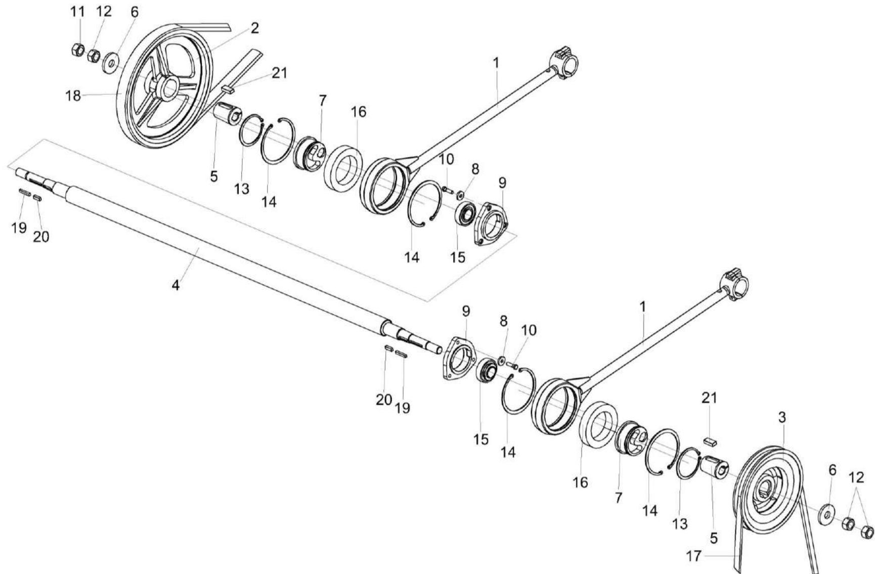
Рисунок 11 – Установка шатуна КЗР 0202030Е и шкивов КЗК-5-4-0202120, КЗК-12-0202111А
