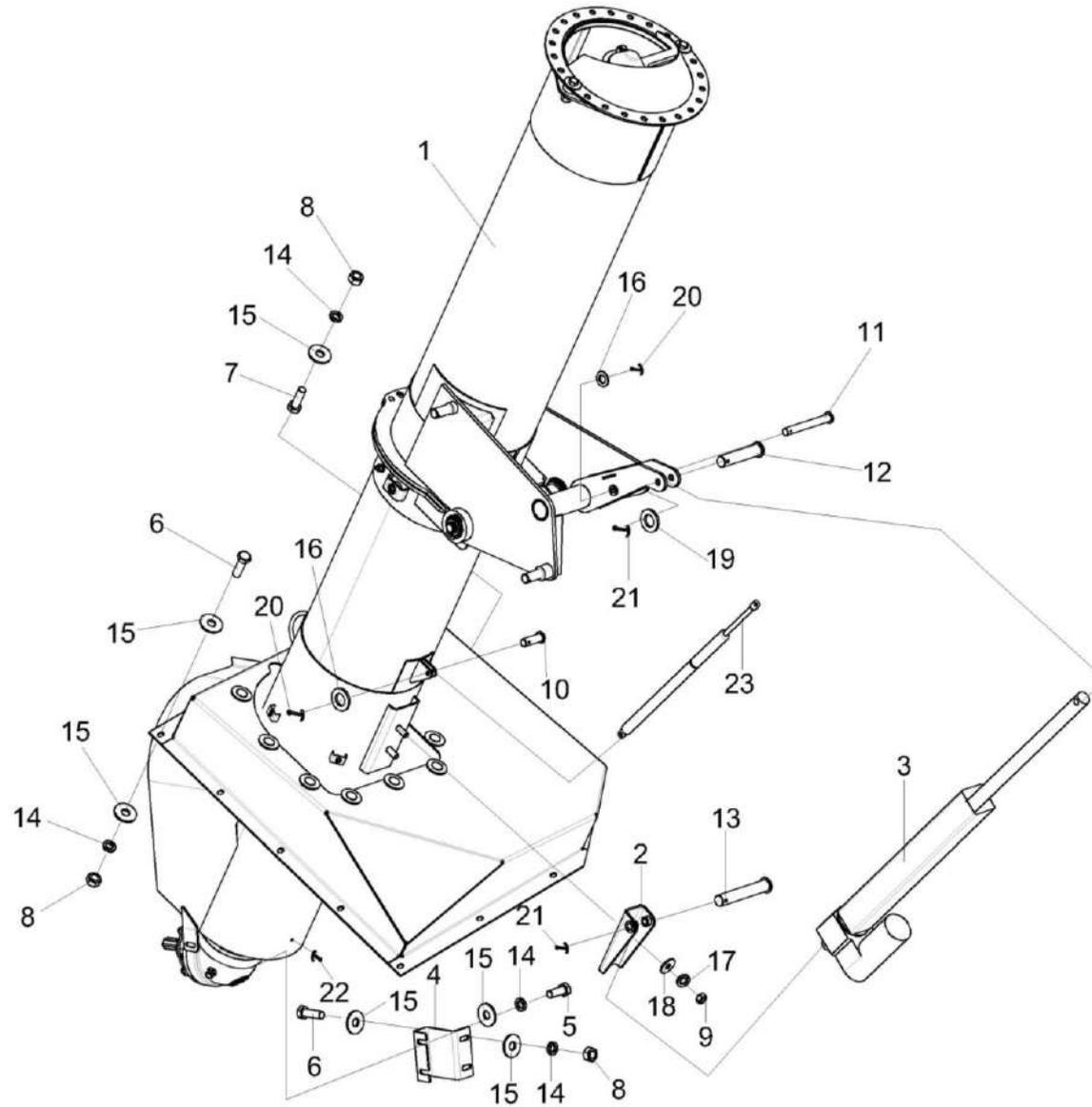
Рисунок 103 – Установка шнека загрузного КЗК-3321-1-0216000А
