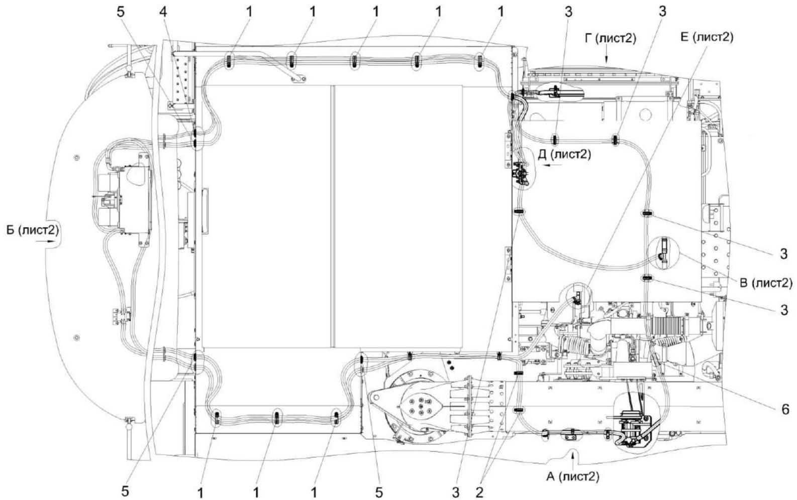
Рисунок 167 – Установка оборудования кондиционера КЗК-12-22-0113010 (лист 1)
