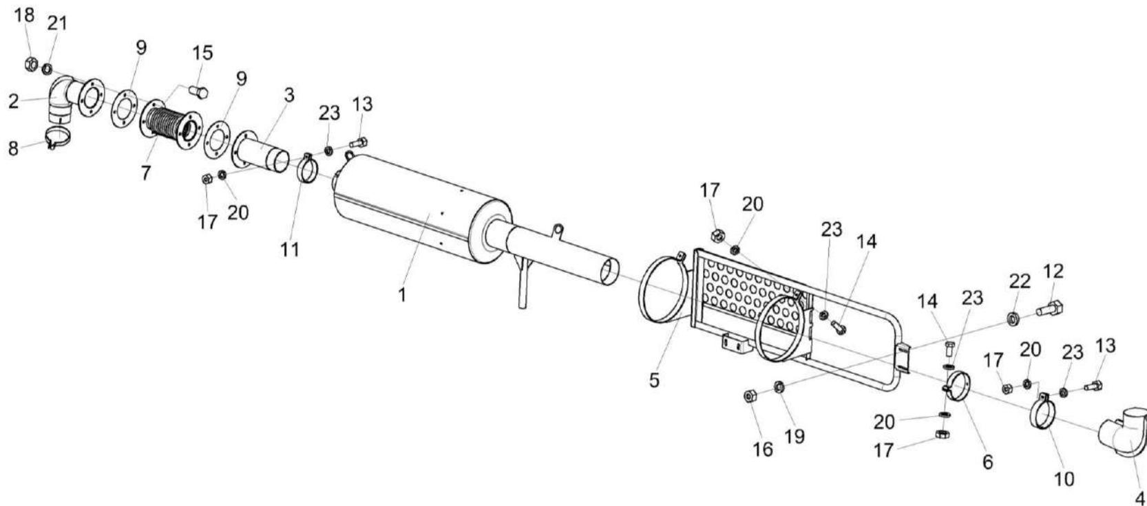
Рисунок 213 – Установка глушителя КЗК-12-3-0126520
