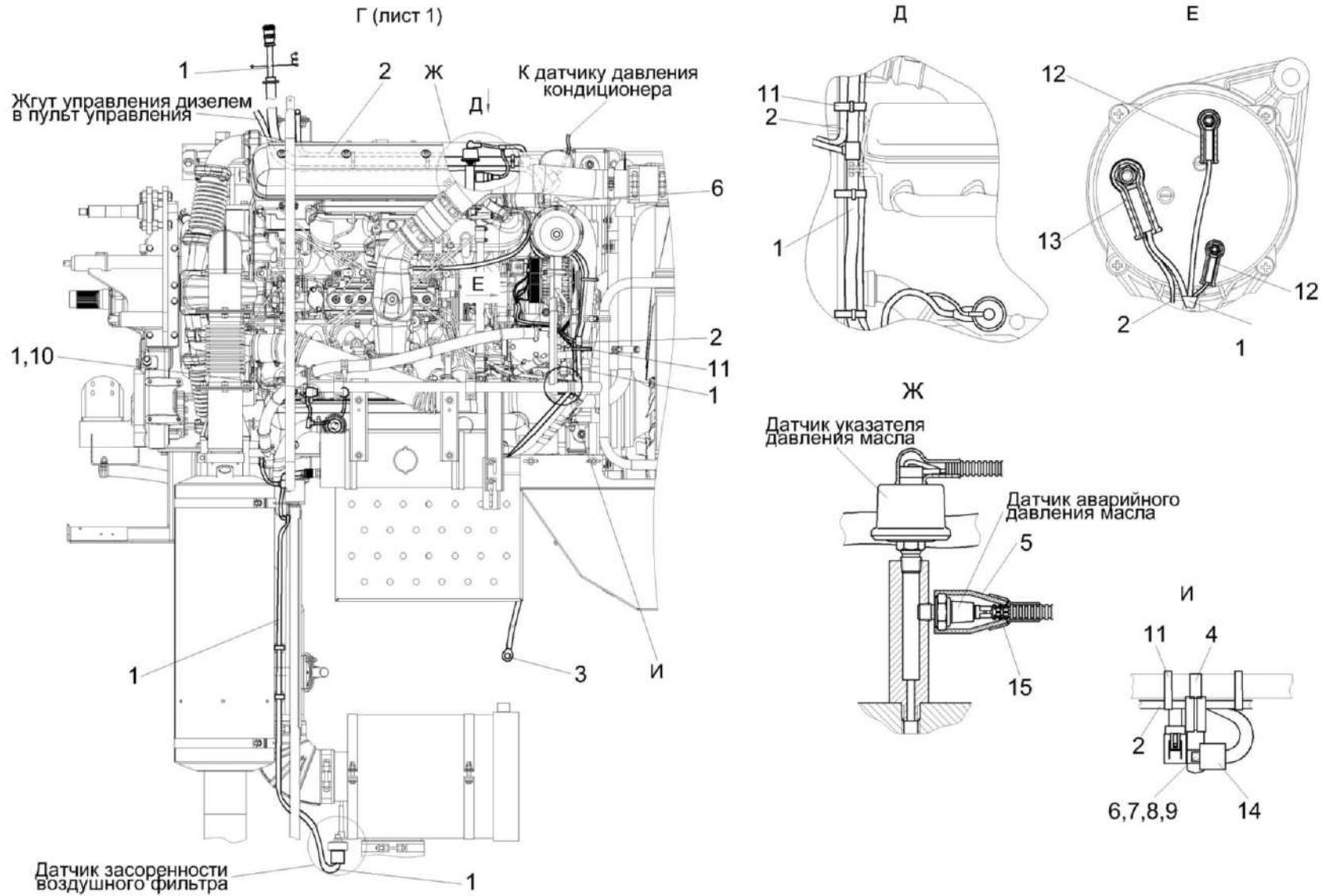
Рисунок 204 – Установка электрооборудования моторной установки КЗК-12-23-0726000 (лист 3)
