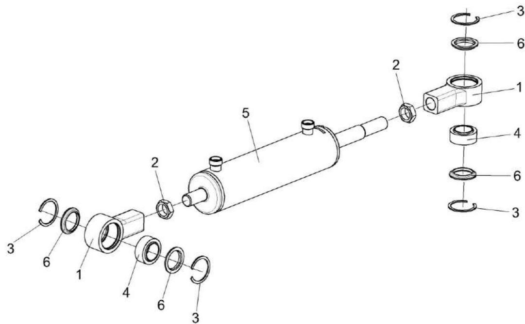
Рисунок 69 – Гидроцилиндр УЭС-7-0109200
