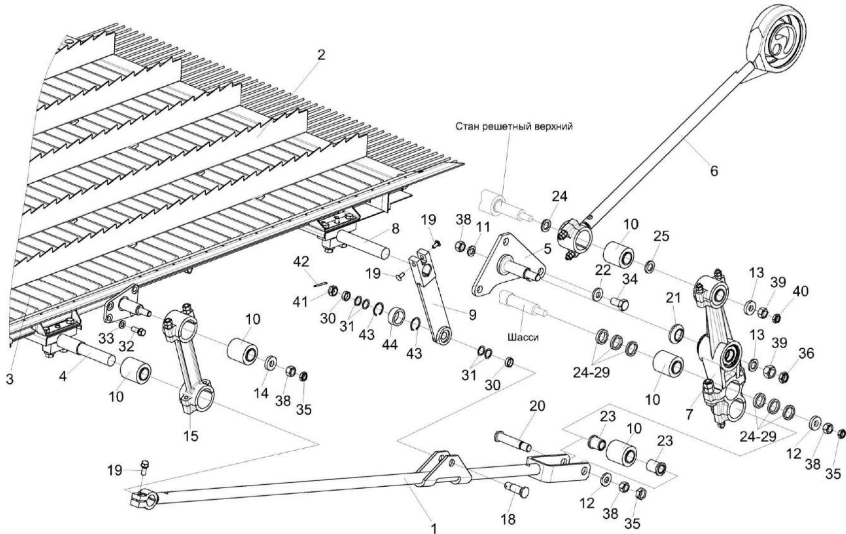
Рисунок 14 – Установка привода доски стрясной КЗК-12-0280200 (вид слева)
