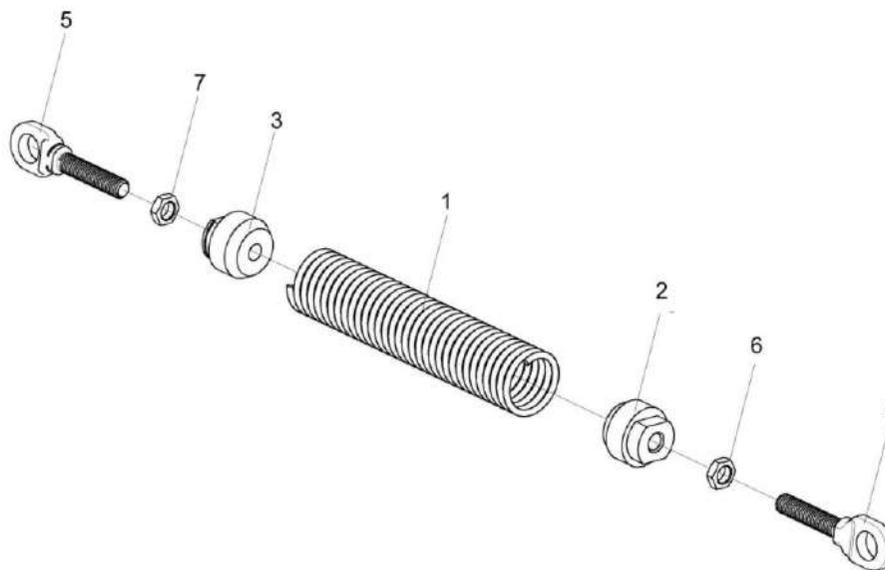
Рисунок 209 – Пружина КЗС 0131210
