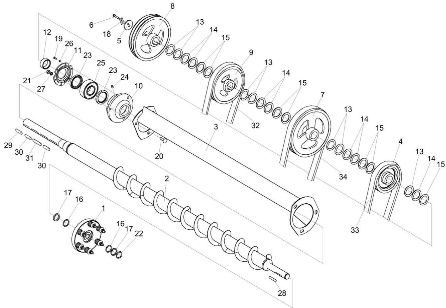
Рисунок 8 – Установка шкивов на шнек распределительный КЗК-810-1-0218010
