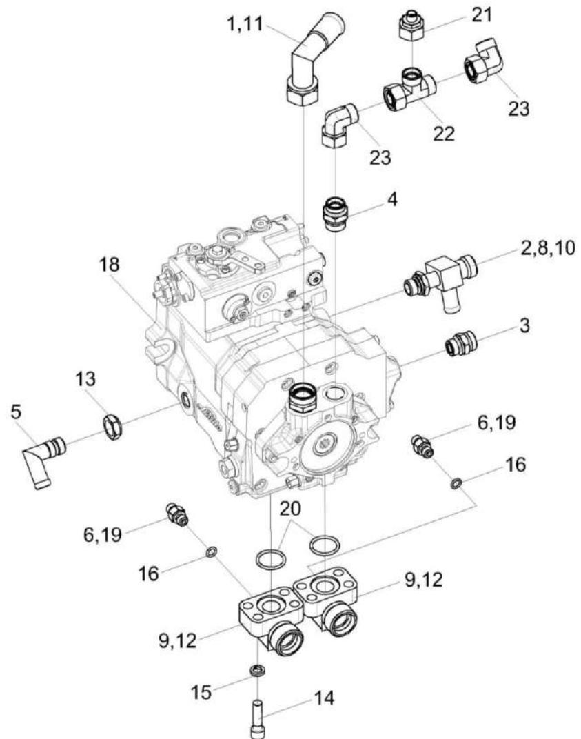
Рисунок 260 – Гидронасос КЗК-12-22-0601100
