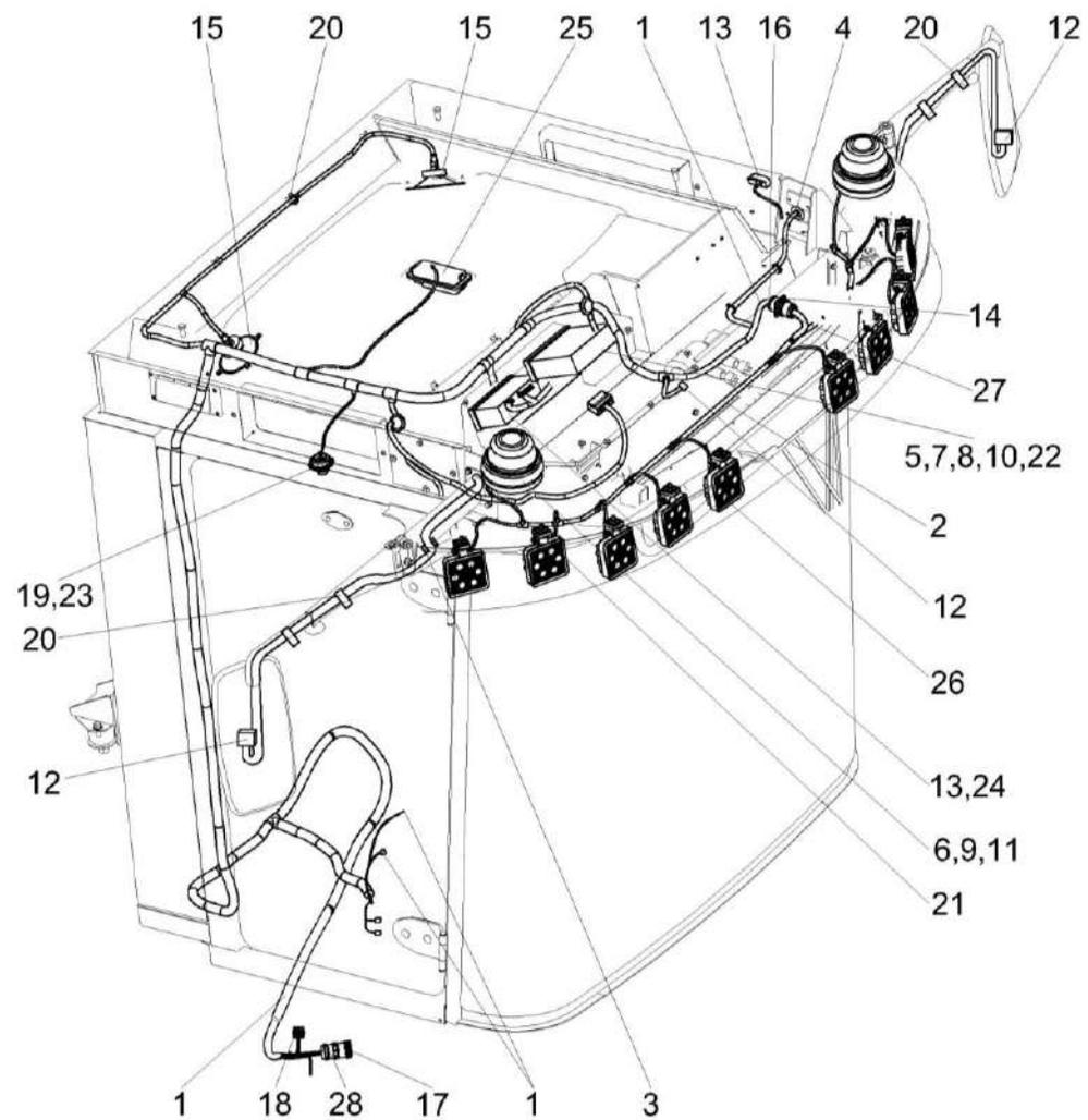
Рисунок 298 - Установка электрооборудования кабины КЗК-12-22-0722000
