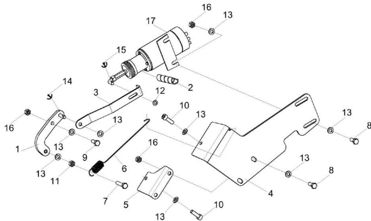
Рисунок 176 – Установка привода КЗК-12-22-0119690А
