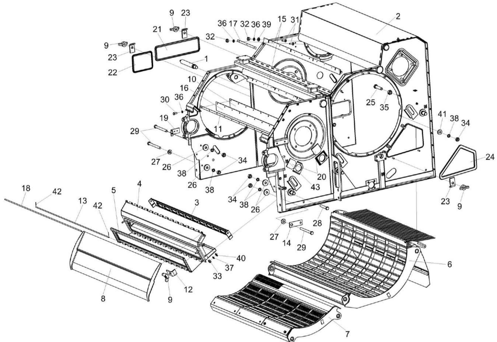
Рисунок 31 – Аппарат молотильный КЗК-12-22-1-0102000 (камнеуловитель и подбарабанье)
