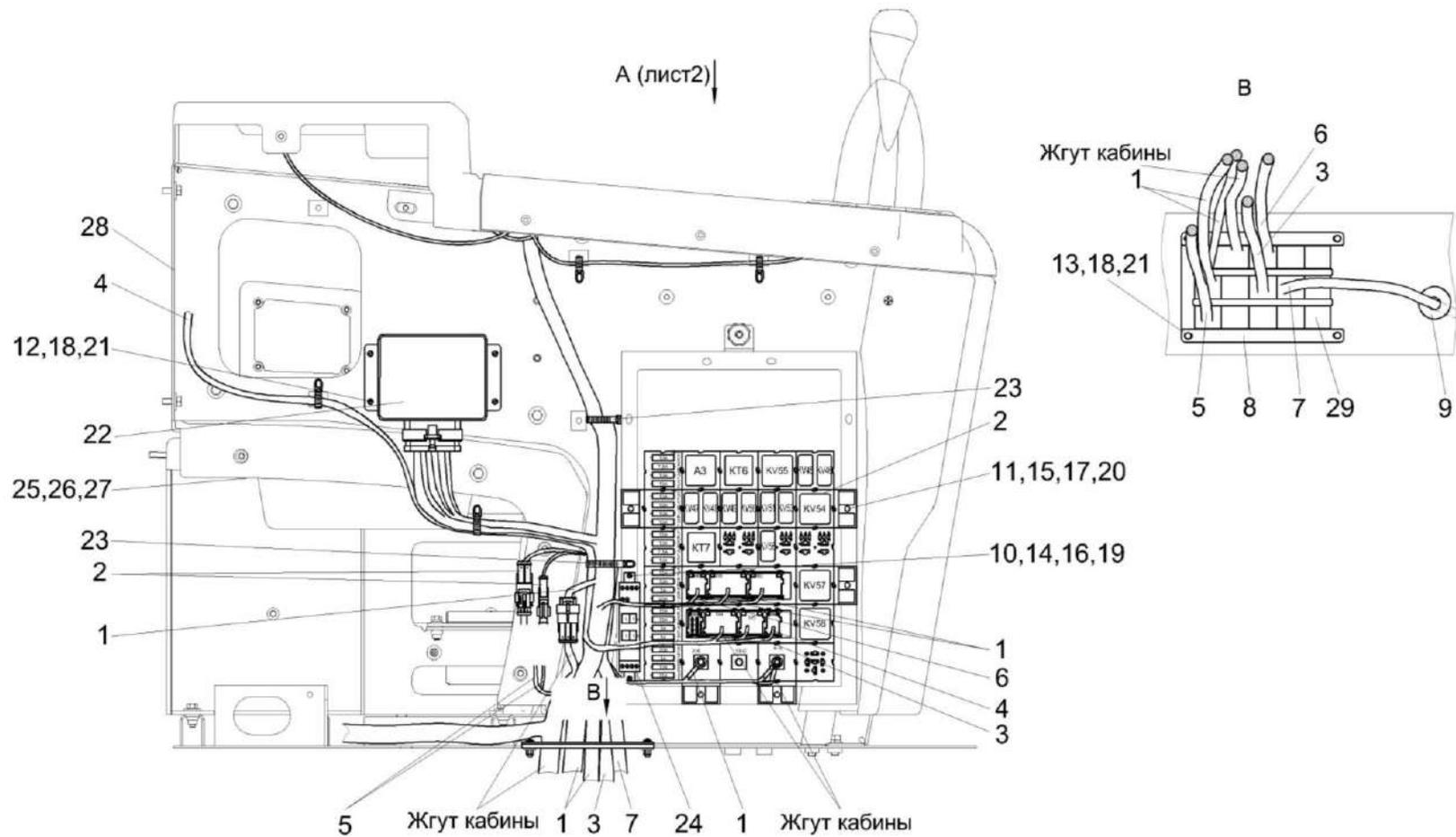
Рисунок 296 - Установка электрооборудования пульта управления КЗК-12-23-0725000 (лист 1)
