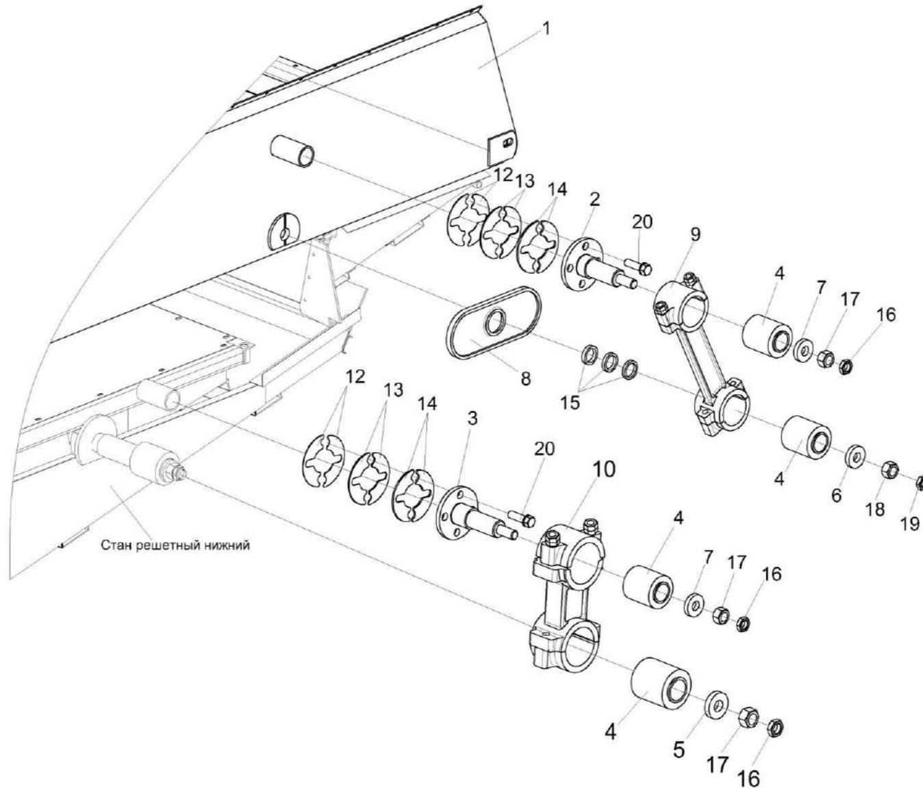
Рисунок 18 – Установка привода стана решетного верхнего КЗК-3219-0260000А
