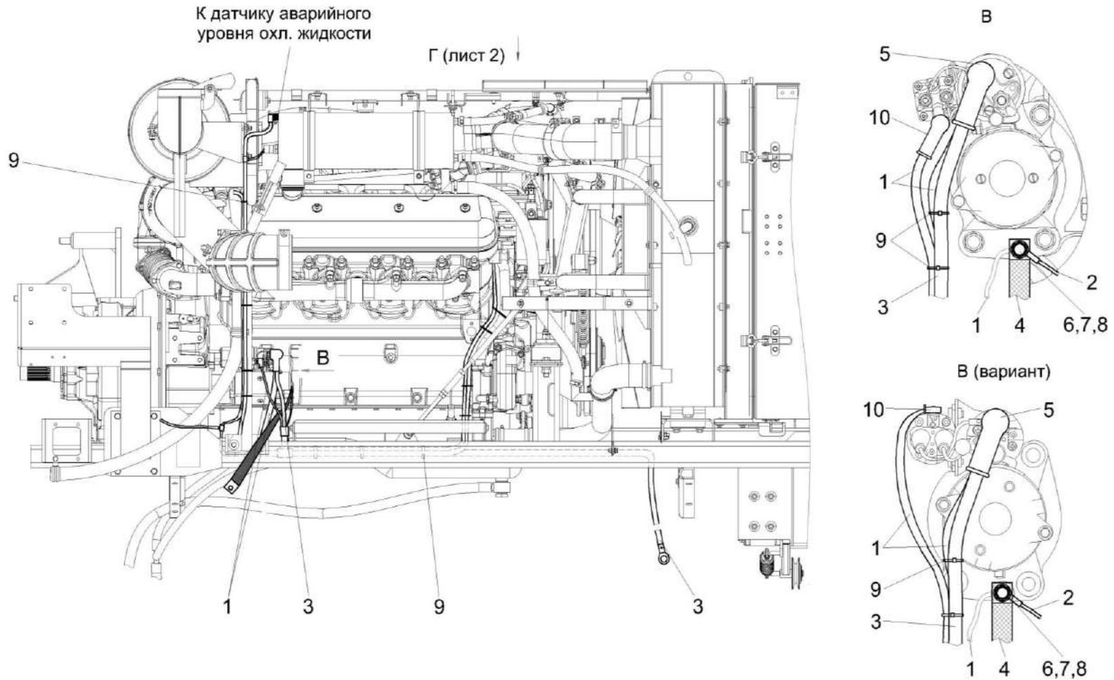
Рисунок 203 – Установка электрооборудования моторной установки КЗК-12-23-0726000 (лист 2)
