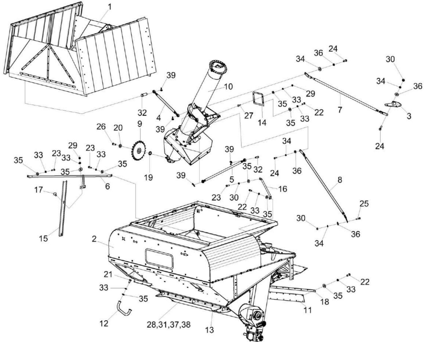
Рисунок 91 – Установка бункера КЗК-3321-1-0203000-02
