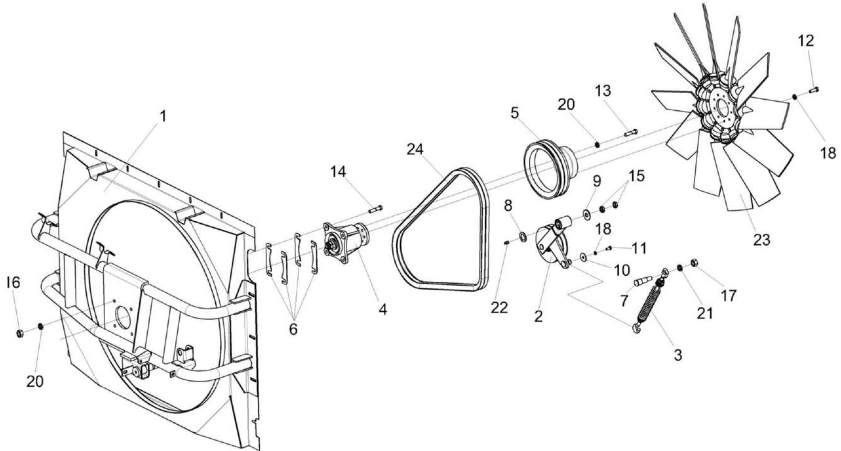
Рисунок 190 – Установка вентилятора КЗК-12-3-0126700
