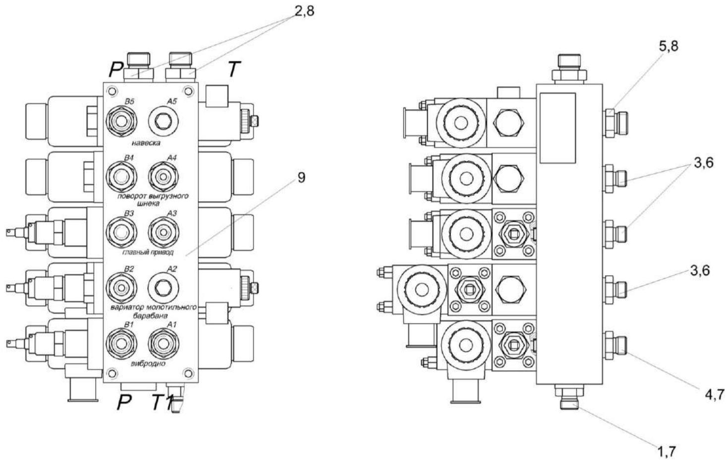
Рисунок 271 – Гидроблок пятисекционный КЗК-10-1-0602310
