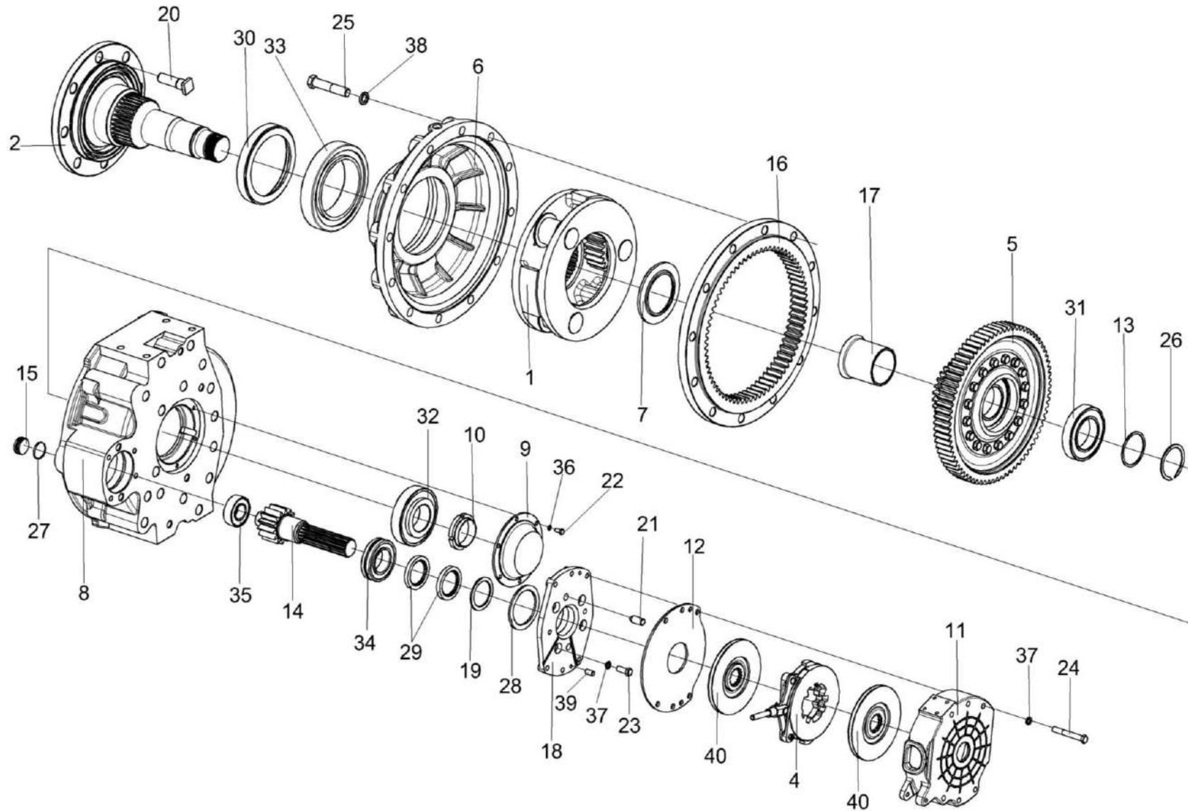
Рисунок 74 – Редуктор бортовой КЗК-10-0107200 (лист 2)
