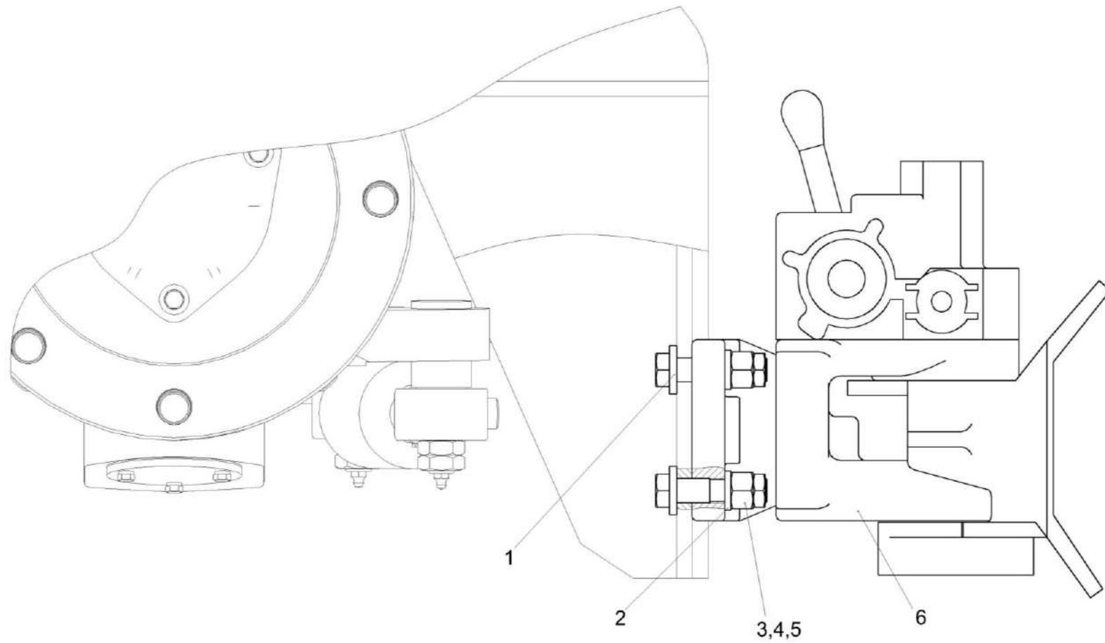
Рисунок 90 – Установка прицепного устройства КЗК-3219-0101030-01
