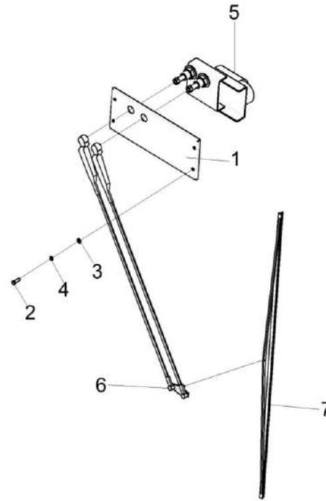
Рисунок 161 – Установка стеклоочистителя УКЗ-01-0101160
