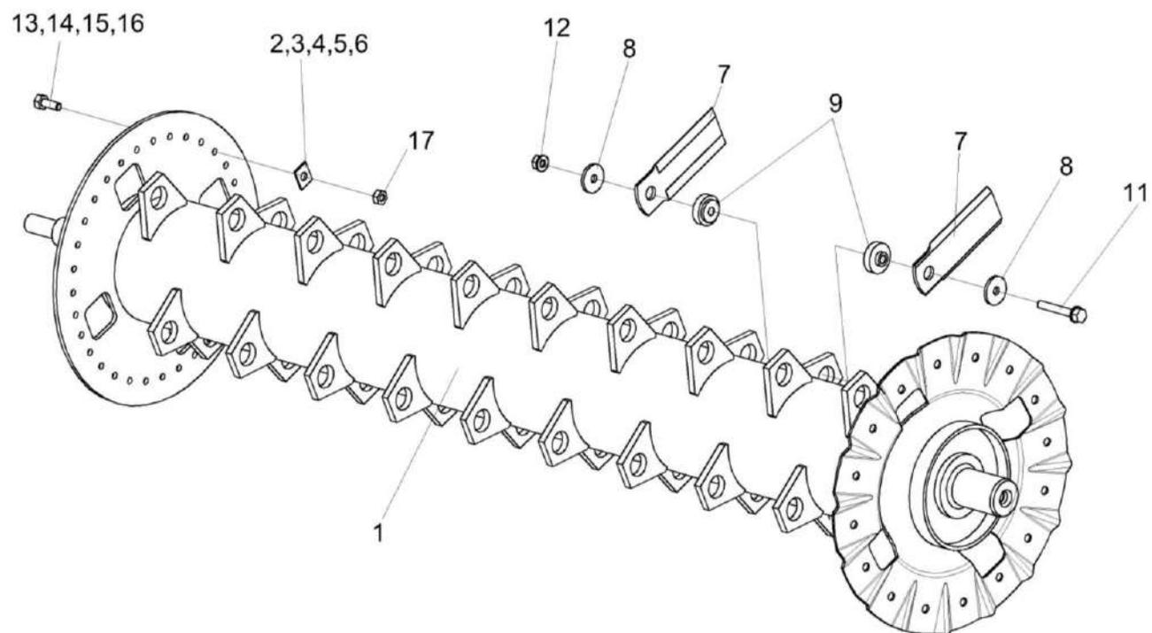
Рисунок 129 – Ротор измельчителя КЗК-12-0290140А
