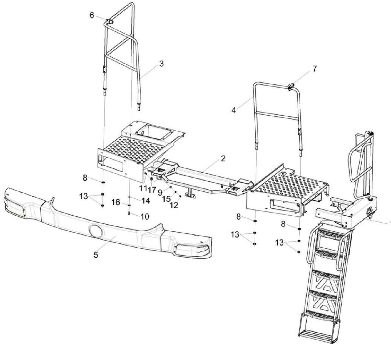
Рисунок 235 - Установка подрамника КЗК-12-22-0133000
