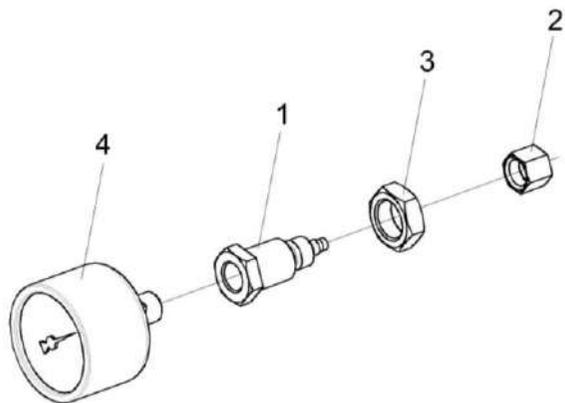
Рисунок 279 – Манометр КЗК-3219-0602390
