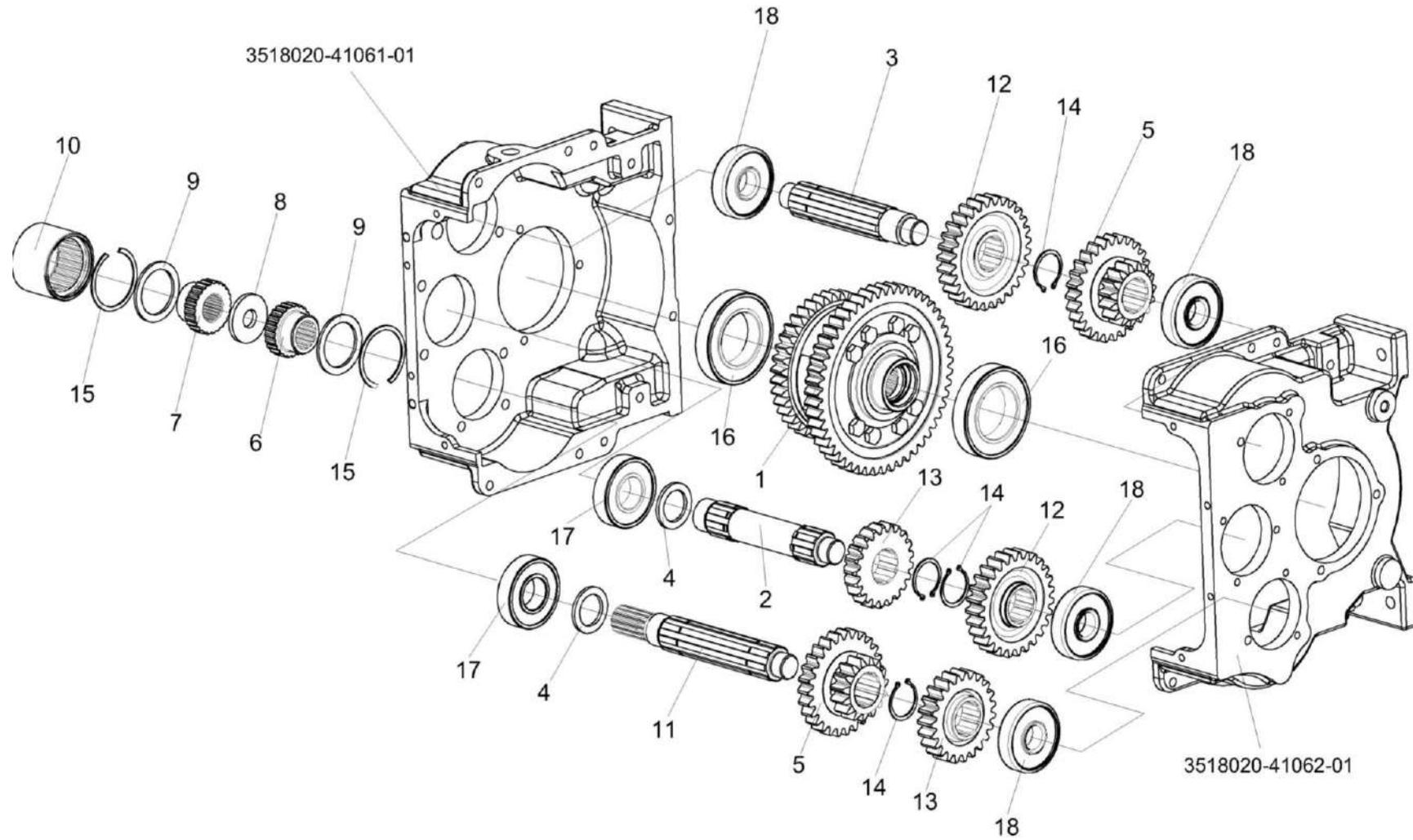
Рисунок 82 – Коробка передач КЗК-12-0107530 (валы и шестерни)
