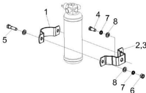
Рисунок 173 – Установка ресивера КЗК-8-3-0113050
