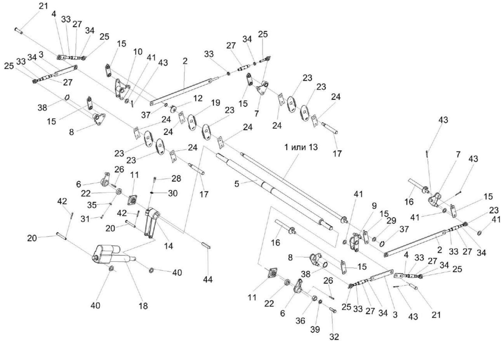
Рисунок 38 – Установка механизма подъема подбарабаний КЗК-12-0115000
