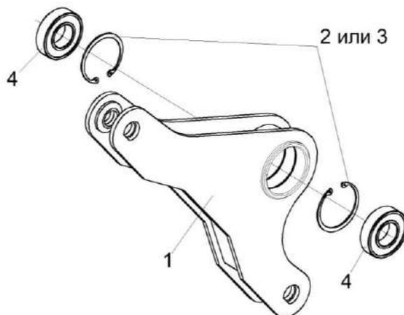
Рисунок 19 – Рычаг КЗК-12-1815110 и КЗК-12-1815110-01
