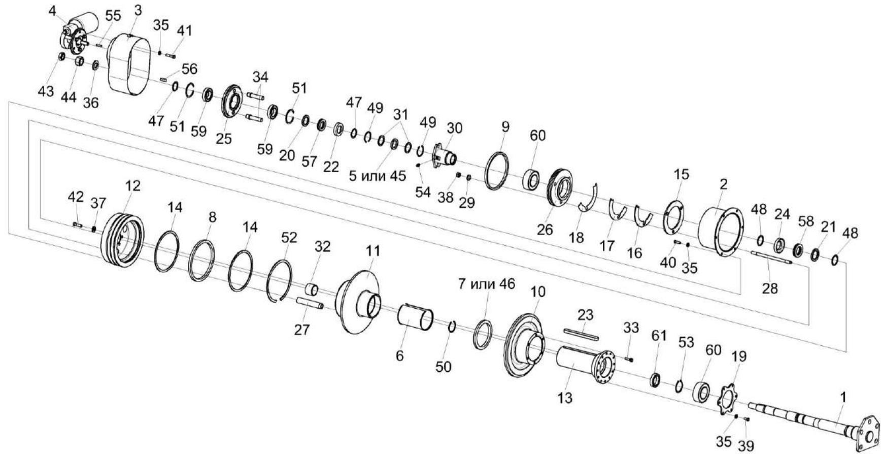
Рисунок 21 – Контрпривод вариатора КЗК-12-0202500В
