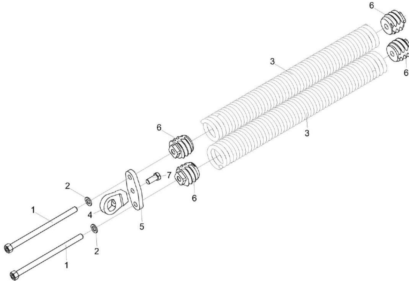
Рисунок 20 – Блок пружин КЗК-12-1835150
