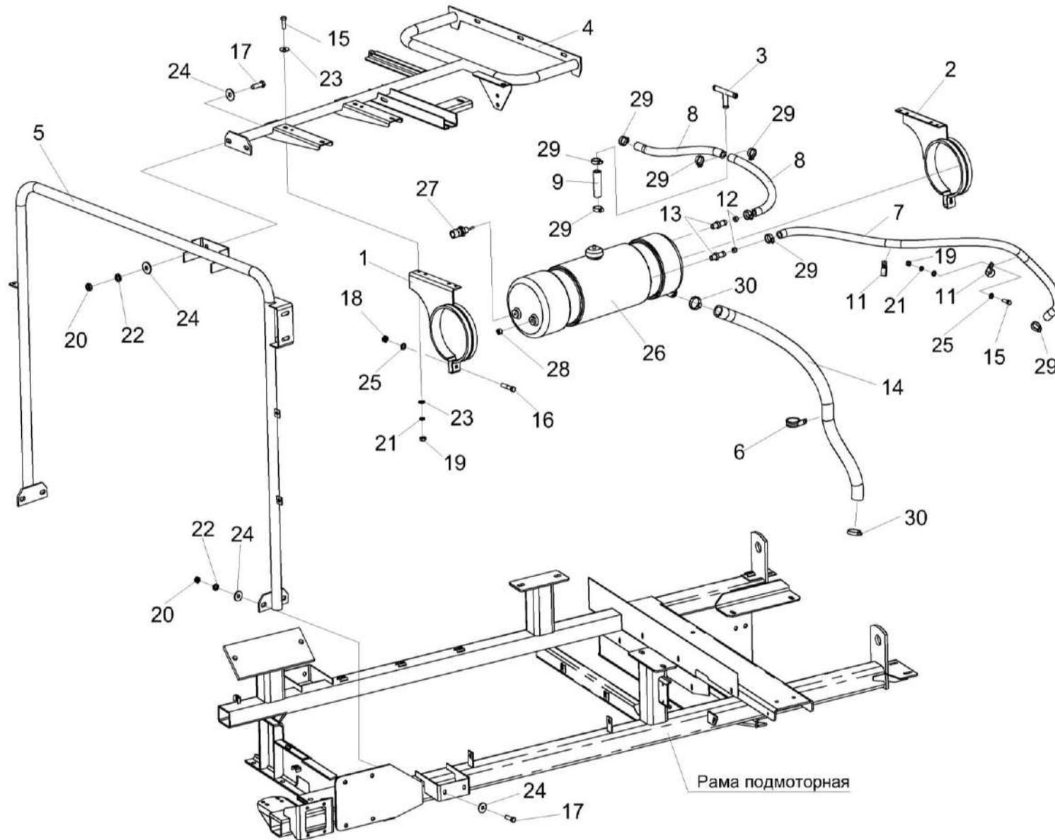
Рисунок 198 – Установка бачка расширительного КЗК-12-3-0106070А
