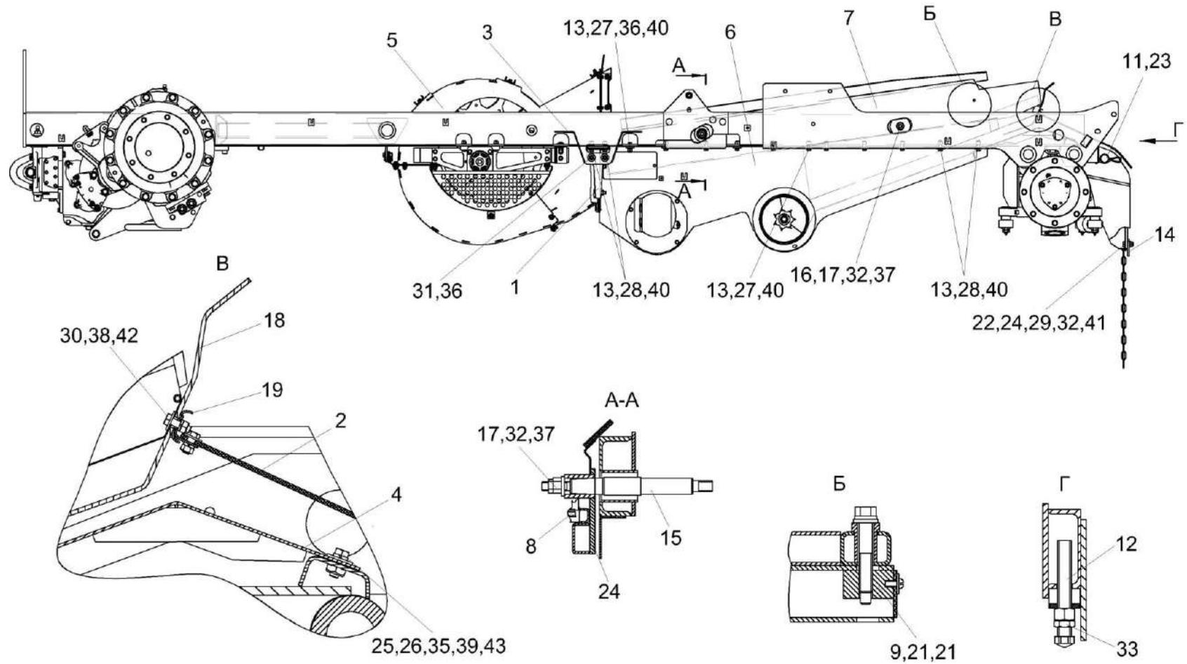
Рисунок 57 – Шасси КЗК-3219-0111000А (вид сбоку)
