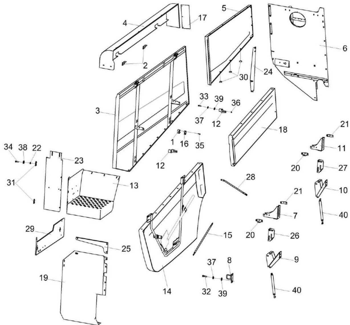
Рисунок 223 – Установка капотов и ограждений КЗК-12-23-0128000 (лист 2)
