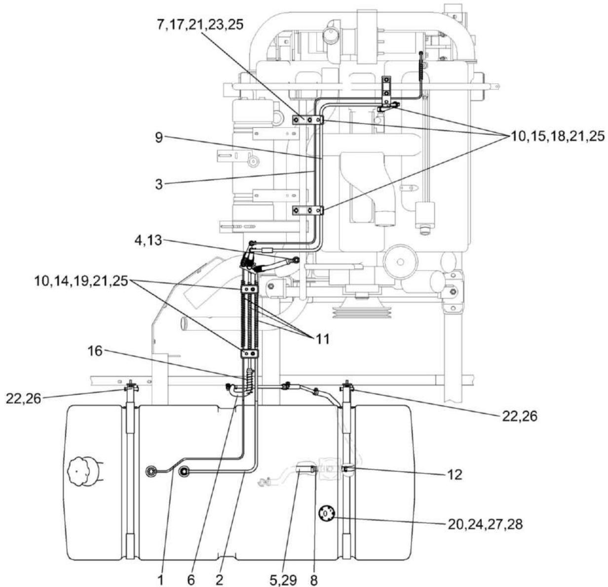
Рисунок 180 – Установка бака топливного КЗК-12-0126600 (лист 2)
