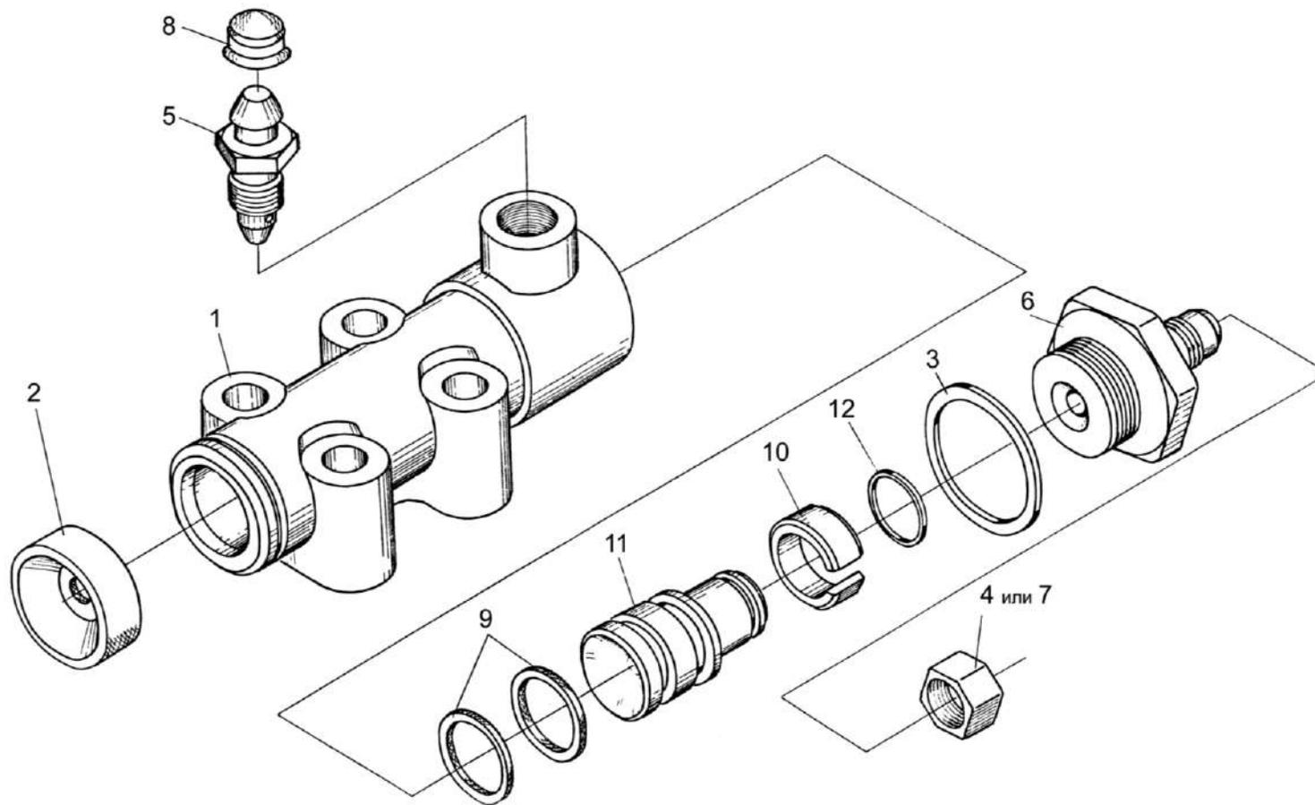
Рисунок 80 – Гидроцилиндр тормоза МК-23М.03.220А
