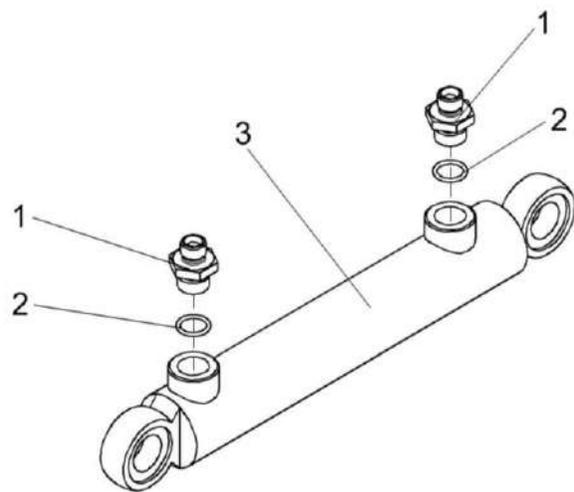
Рисунок 273 – Гидроцилиндр КЗК-12-0602310
