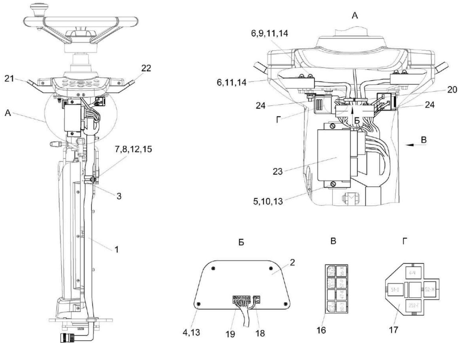
Рисунок 300 – Установка электрооборудования колонки рулевой КЗК-810-0723000
