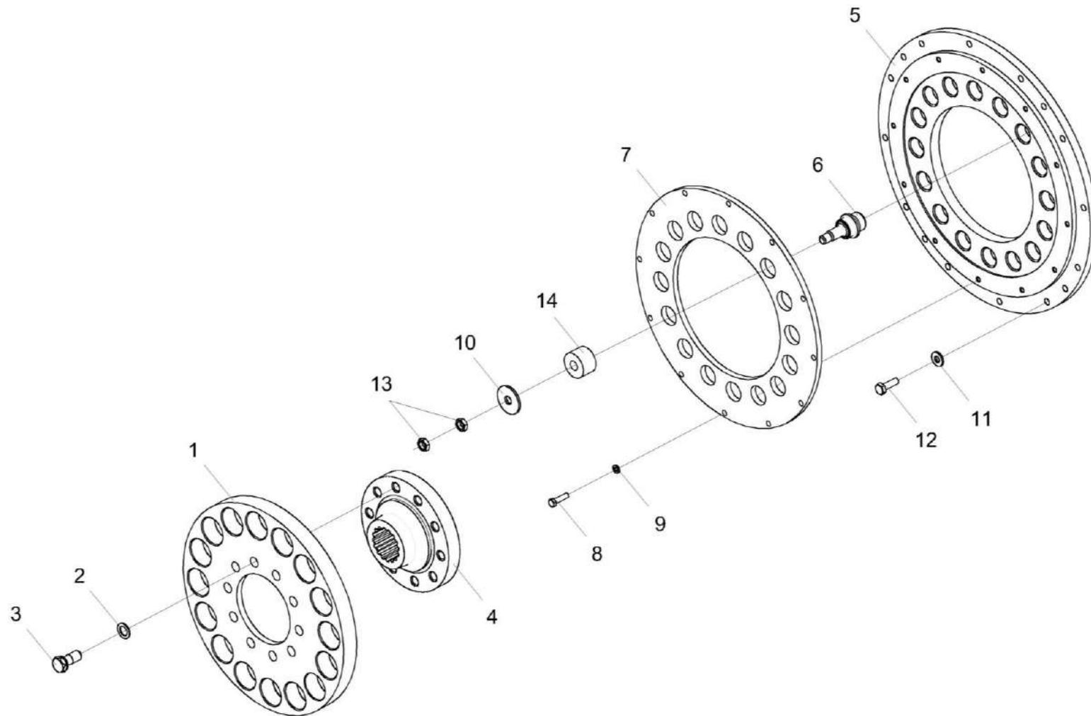
Рисунок 186 – Установка муфты КЗК-12-16-0106020
