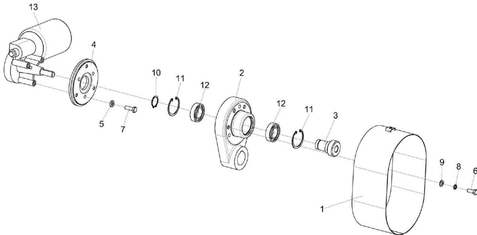
Рисунок 22 – Привод КЗК-12-0202690Б и КЗК-12-0202700
