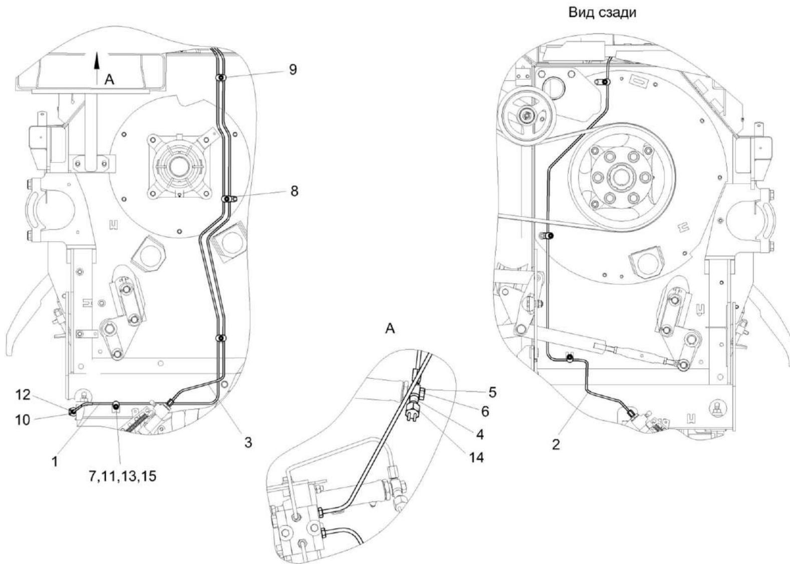
Рисунок 88 – Установка тормозных трубопроводов КЗК-12-22-0119630
