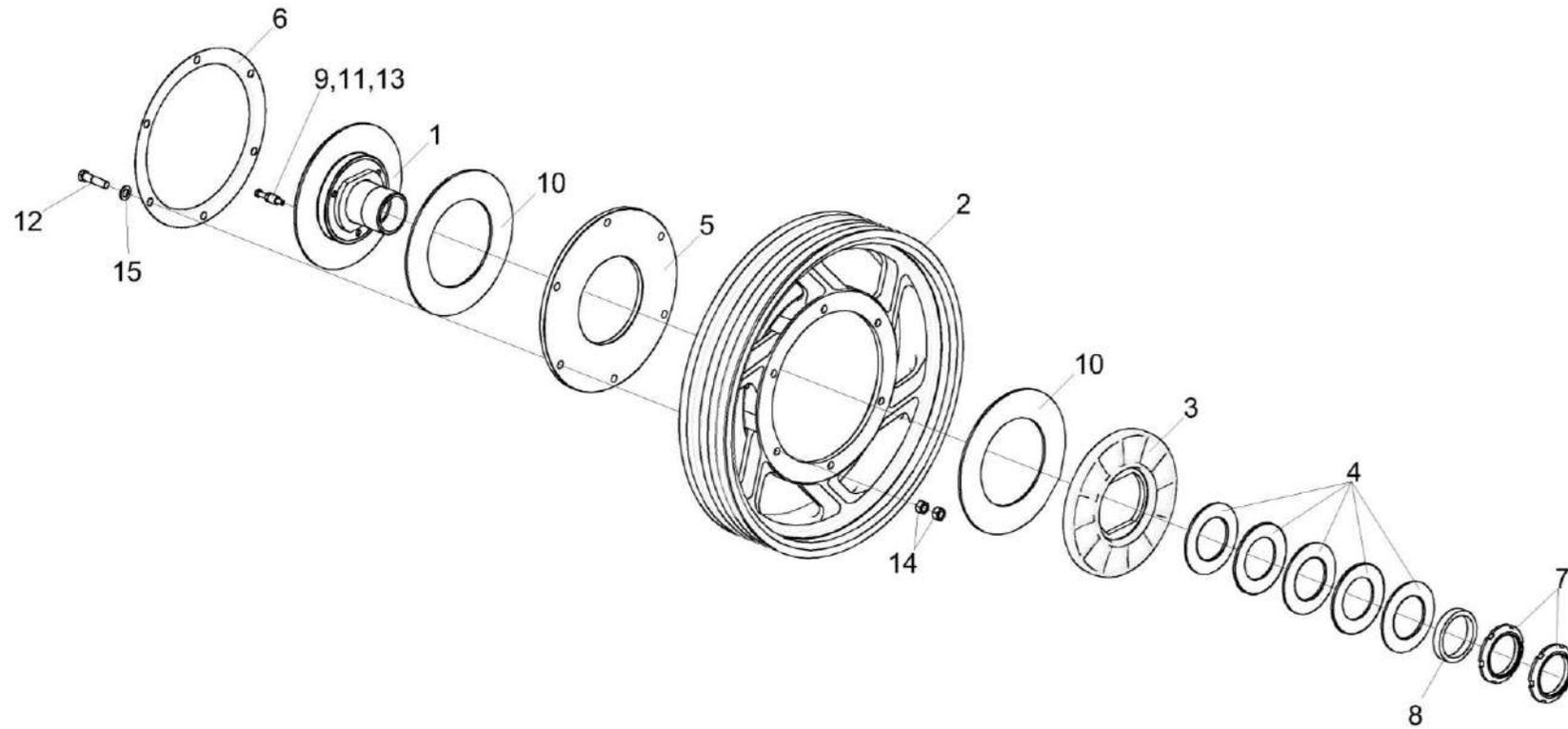
Рисунок 11 – Муфта предохранительная КЗК-12А-1-1803090-05
