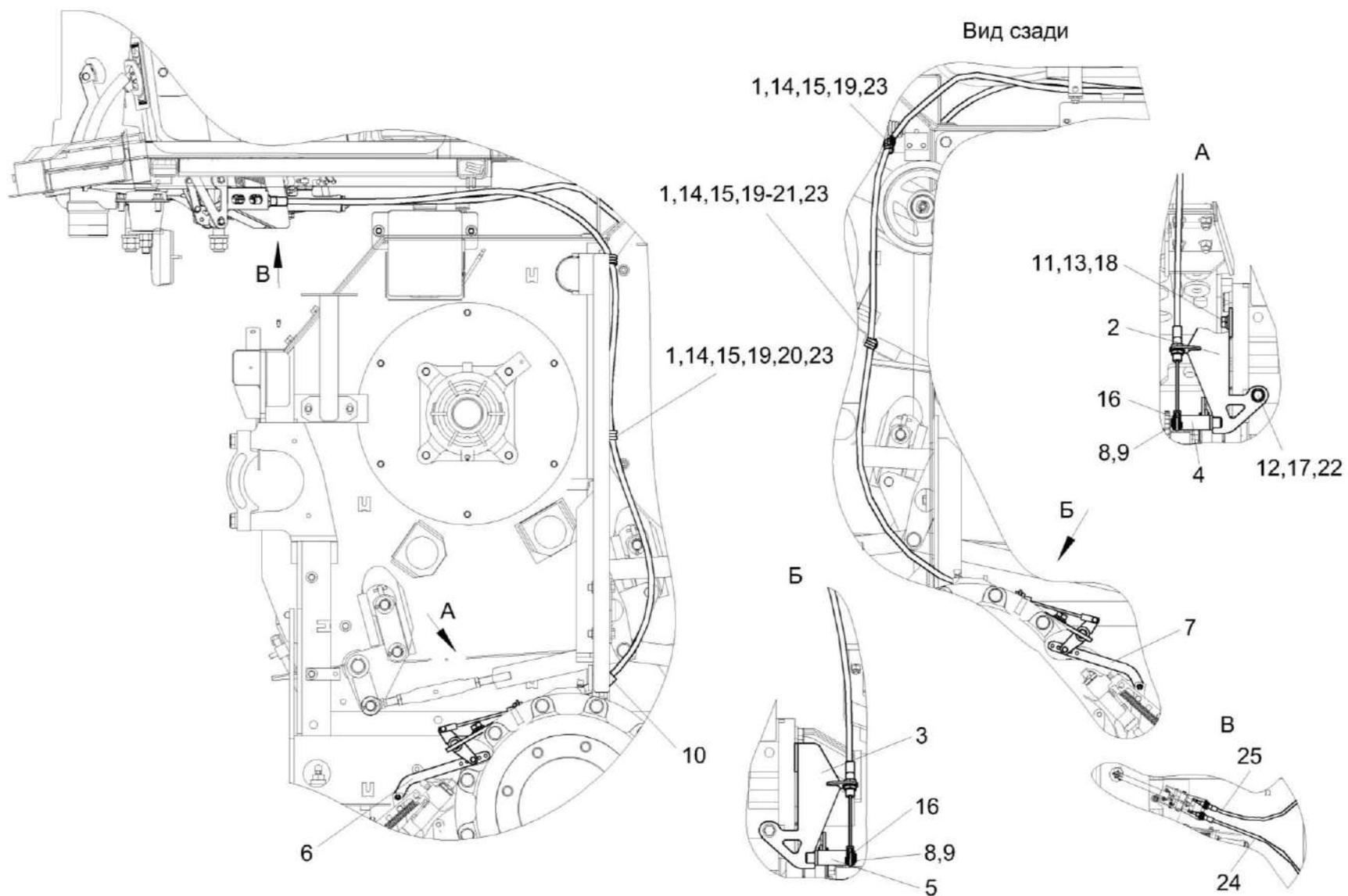
Рисунок 89 – Установка стояночного привода КЗК-12-22-0119610
