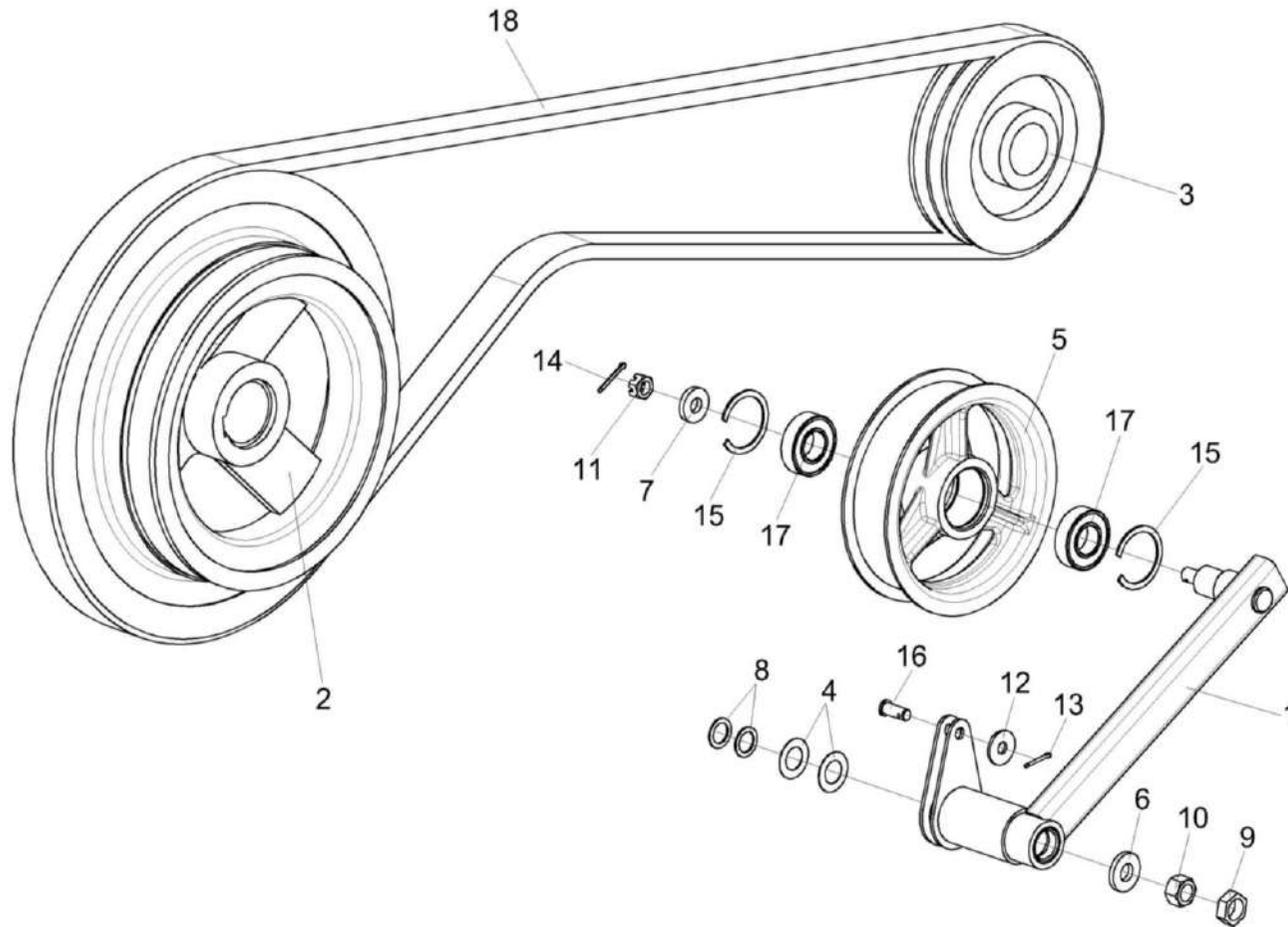
Рисунок 24 – Установка рычага КЗК-12-0202820
