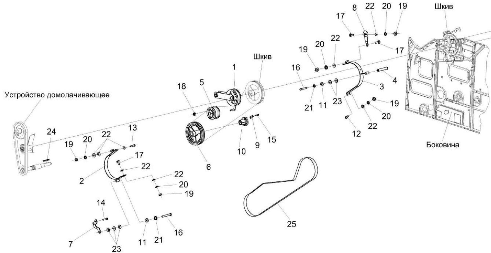
Рисунок 122 – Установка привода выгрузки КЗК-12А-1-0221100 (лист 2)
