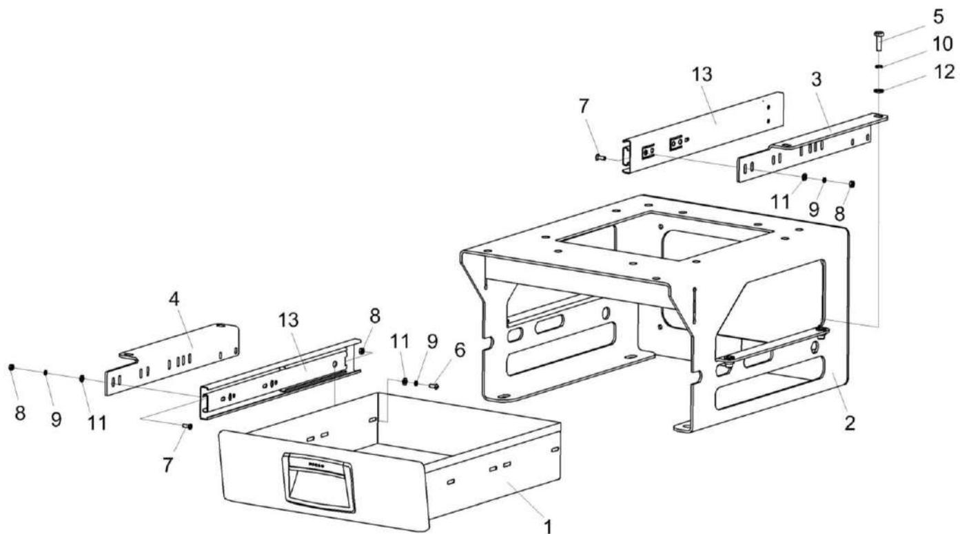
Рисунок 144 – Установка кронштейна УК3-01-0230010
