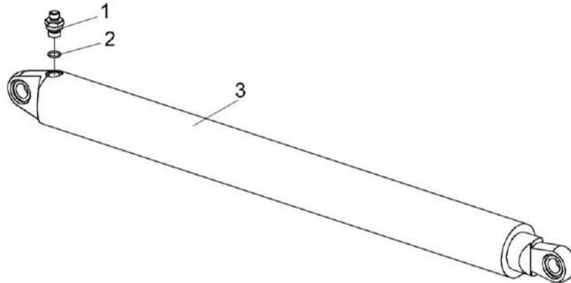
Рисунок 277 – Гидроцилиндр КЗК-12-0602740
