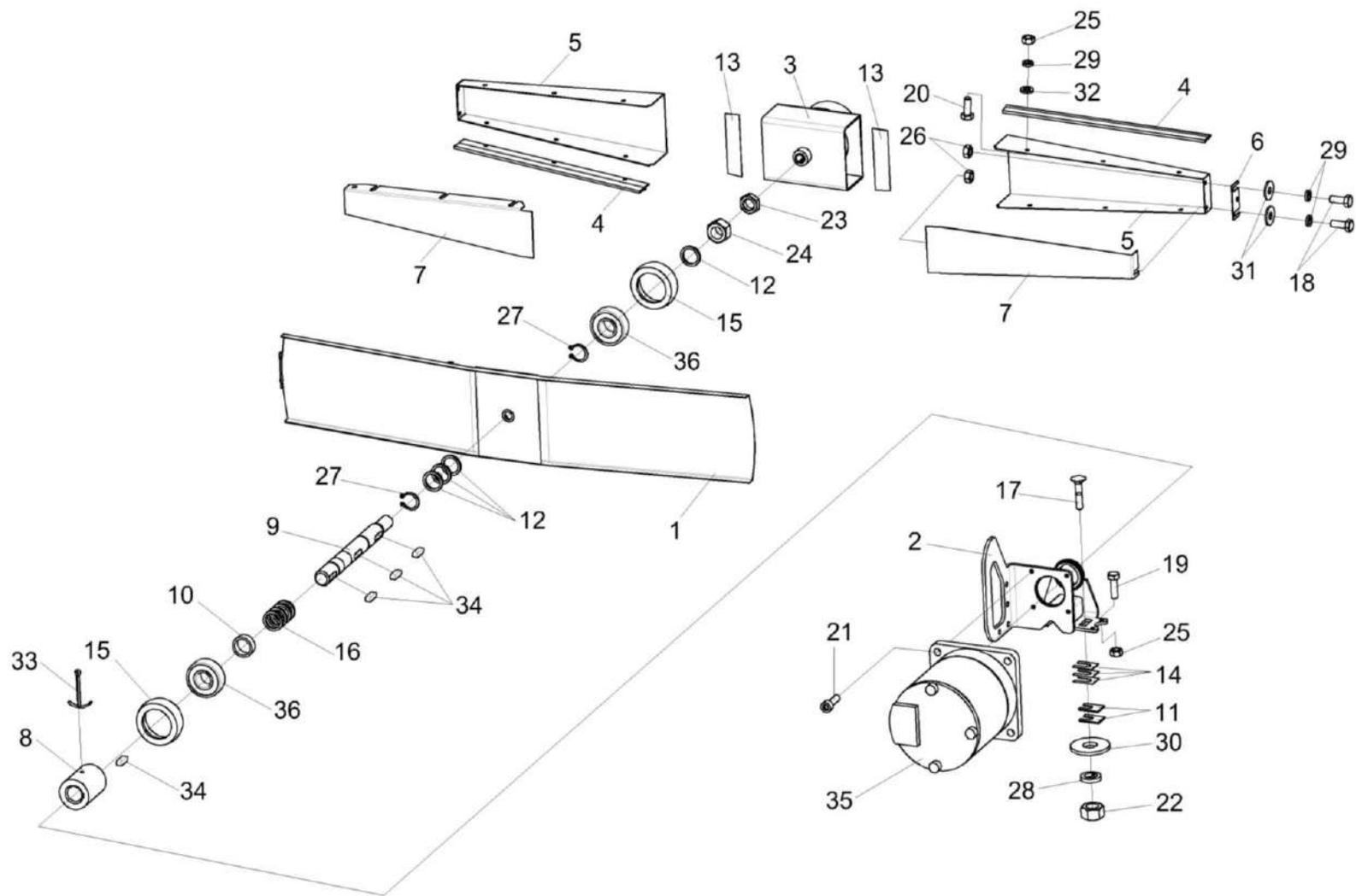
Рисунок 196 – Установка пылесъемника КЗК-12-23-0106130
