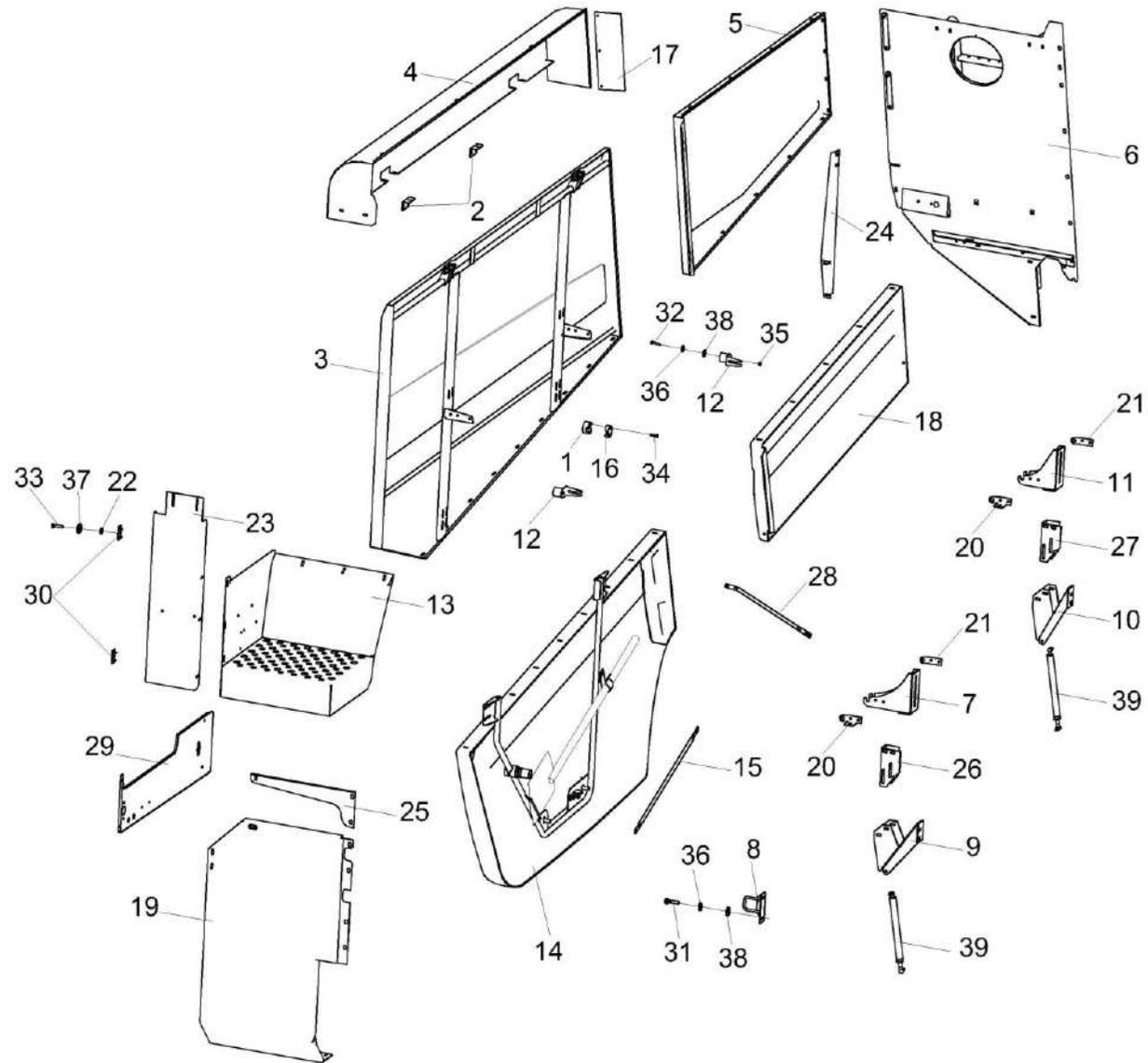
Рисунок 226 – Установка капотов и ограждений КЗК-12-23-0128000-01 (лист 2)
