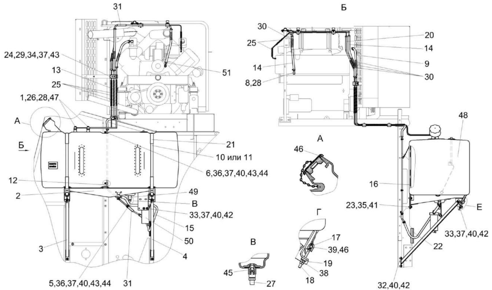
Рисунок 179 – Установка бака топливного КЗК-12-0126600 (лист 1)
