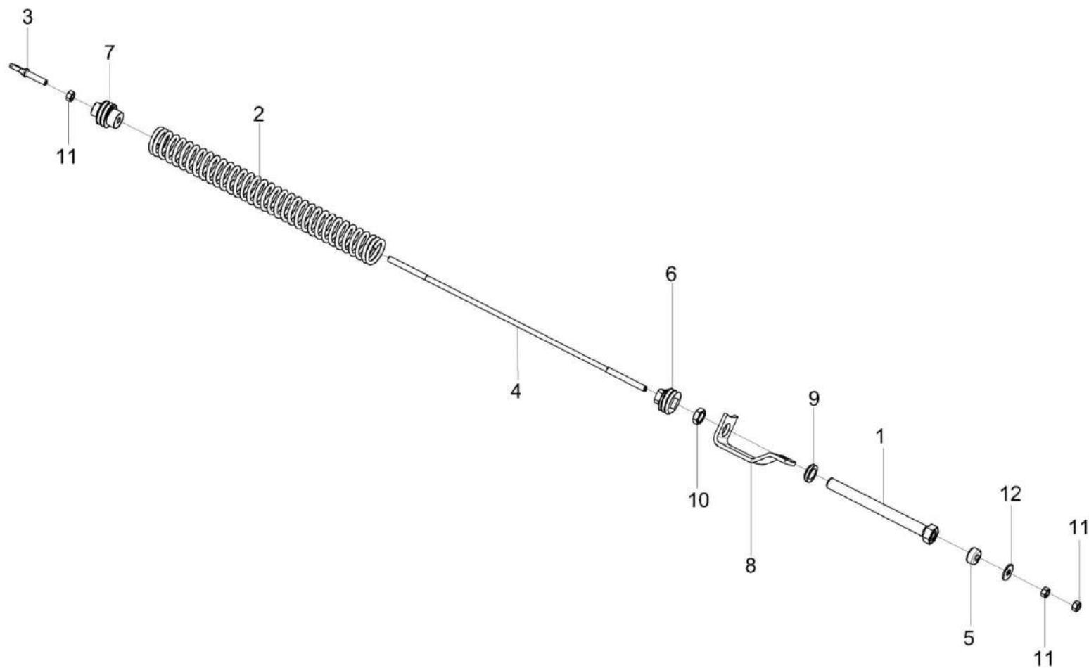
Рисунок 250 – Пружина КЗК-10-0100580
