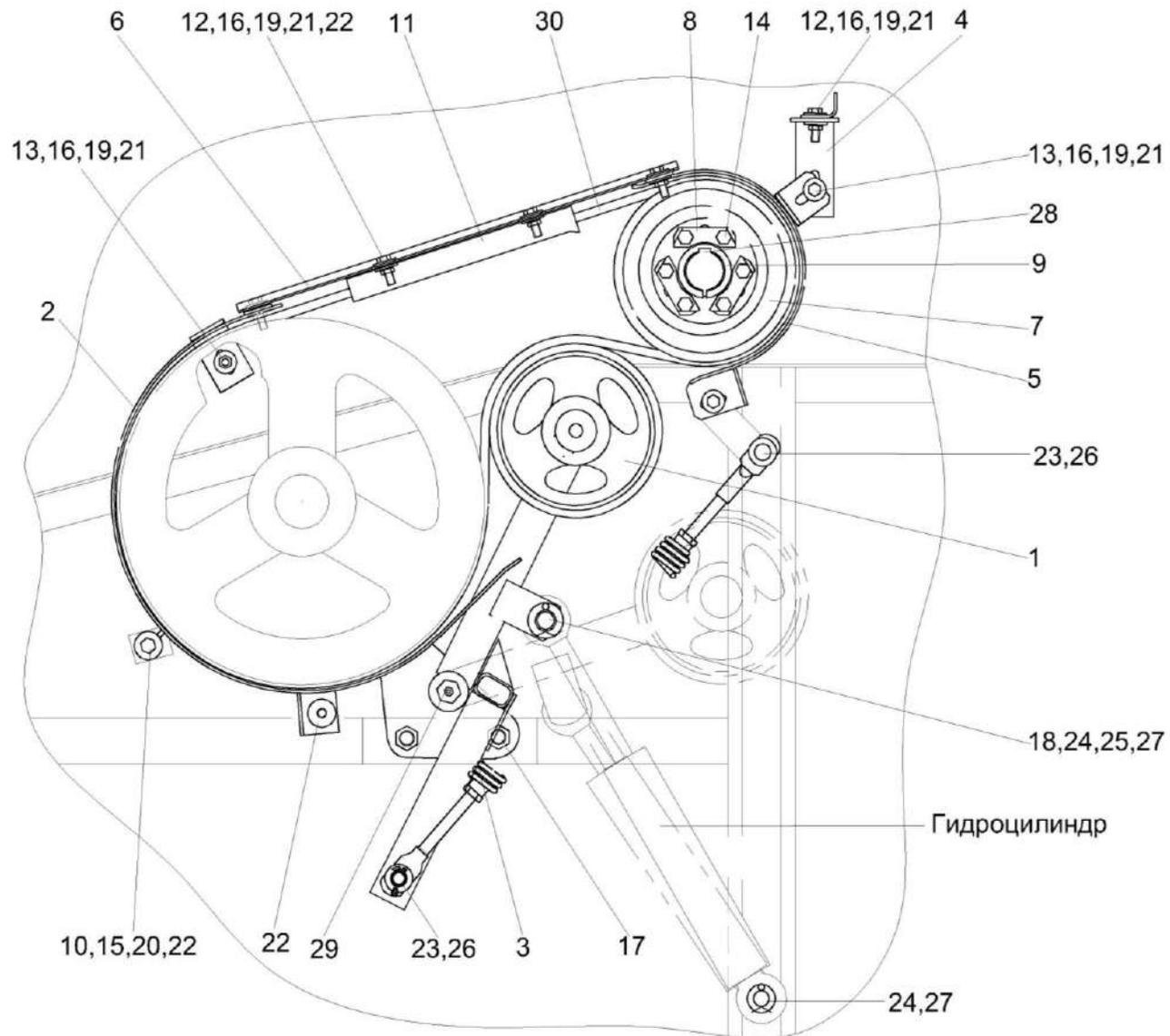
Рисунок 108 – Установка привода вибродна КЗК-12А-1-0223000
