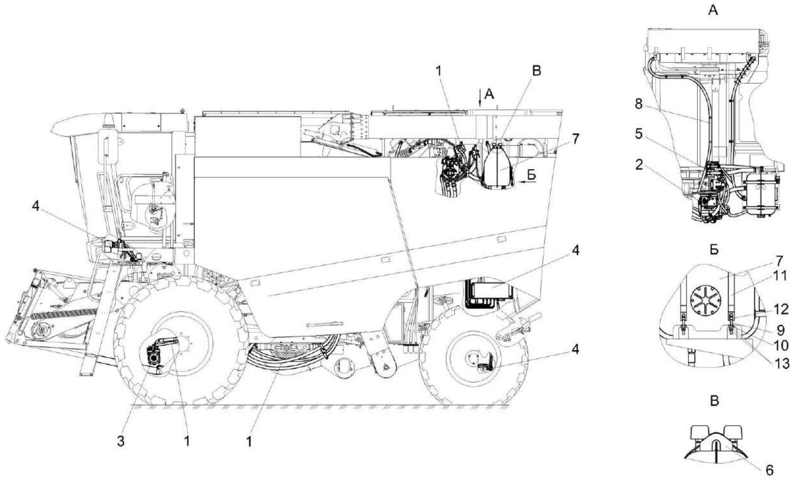
Рисунок 255 – Гидросистема КЗК-12-22-0600000-01
