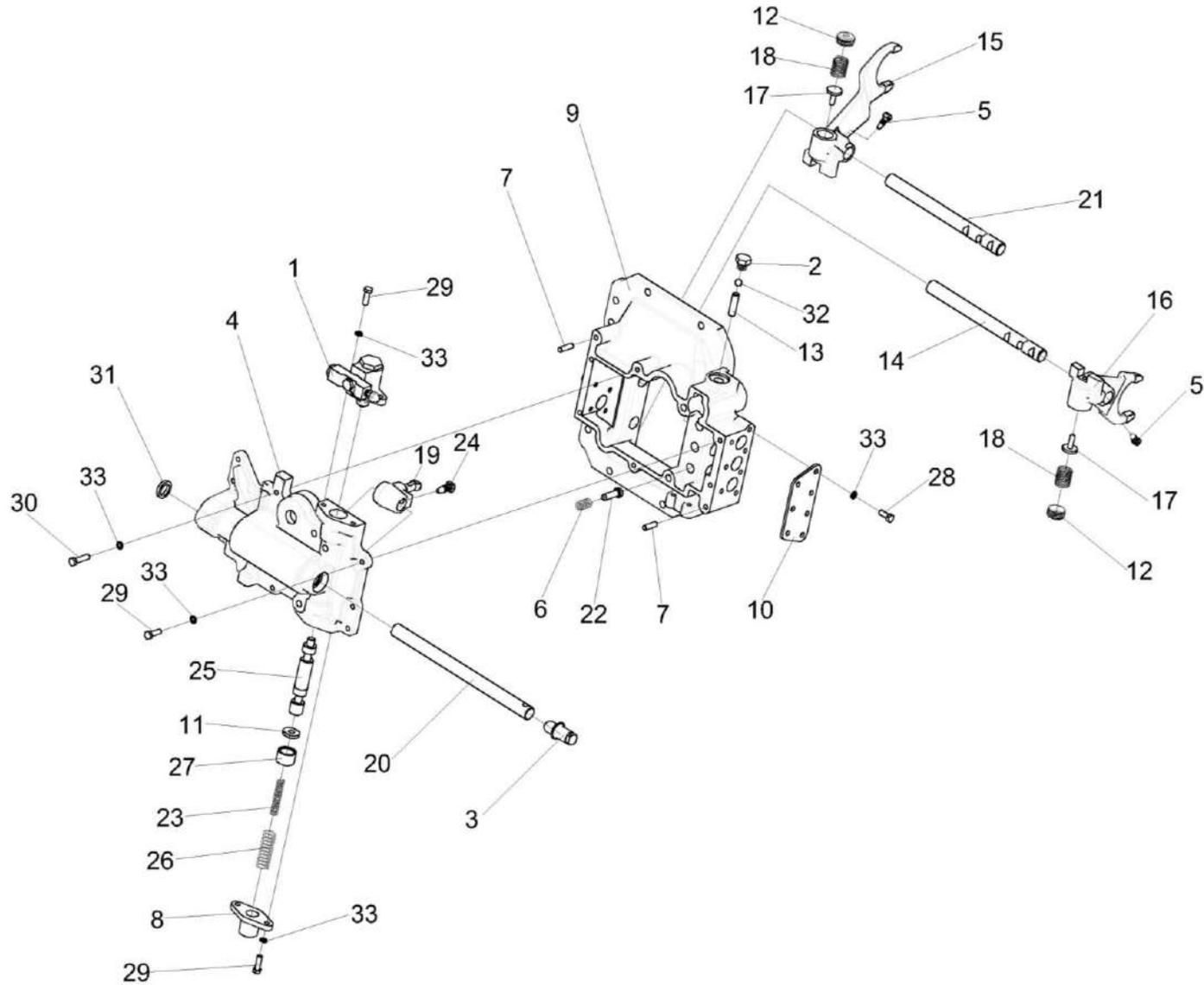
Рисунок 84 – Механизм переключения передач КЗК-12-0107560
