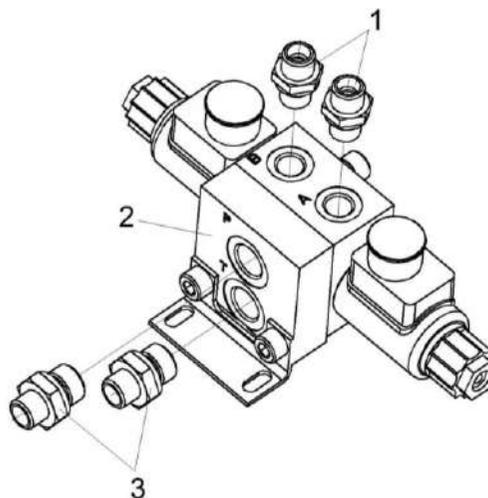
Рисунок 259 – Гидроблок доворота вала мотора ГСТ УЭС-16-0601060
