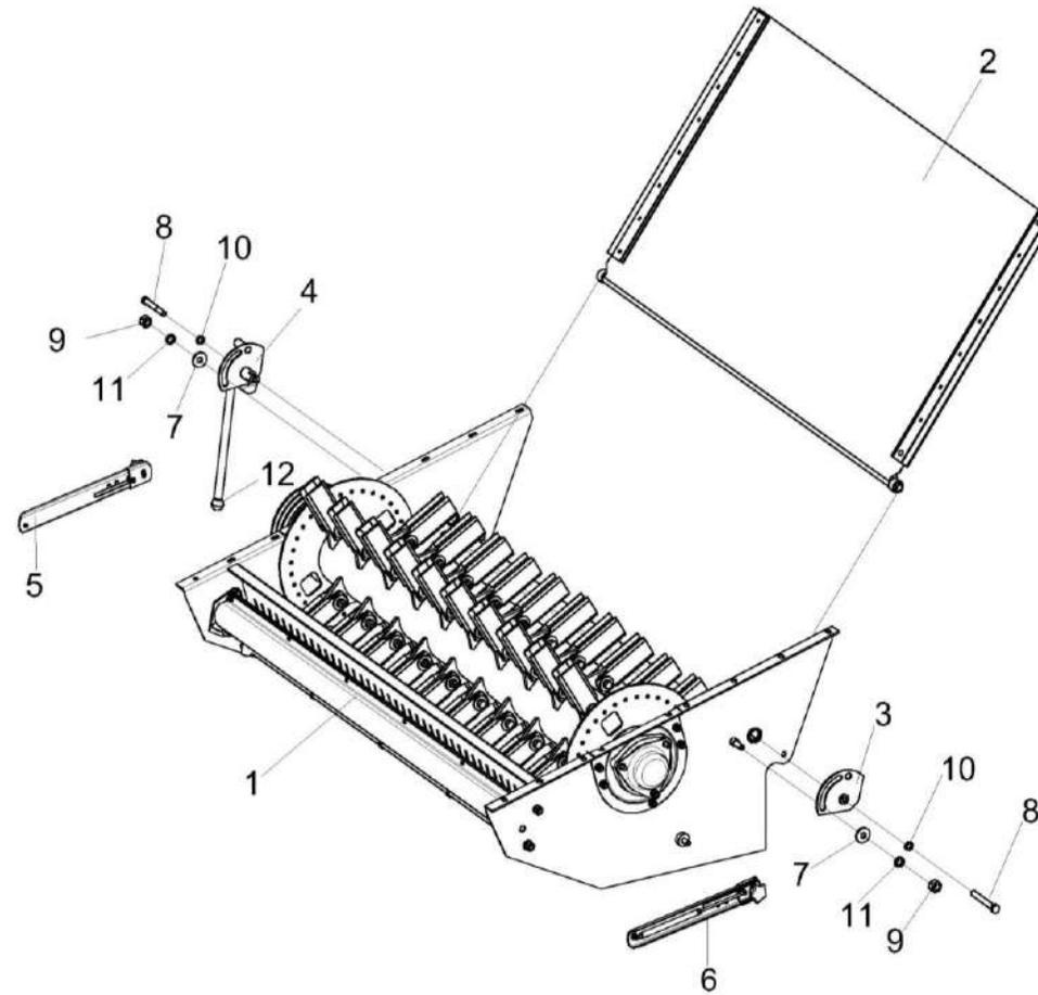
Рисунок 126 – Установка соломоизмельчителя КЗК-12-0290600А (лист 2)
