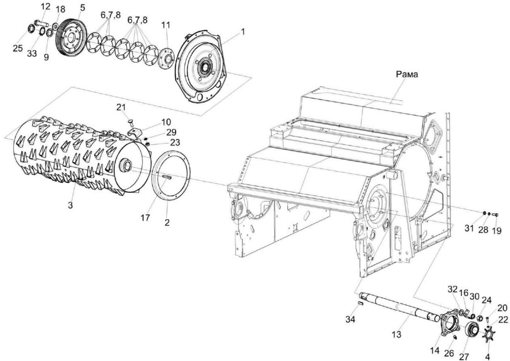
Рисунок 29 – Аппарат молотильный КЗК-12-22-1-0102000 (установка барабана ускоряющего)
