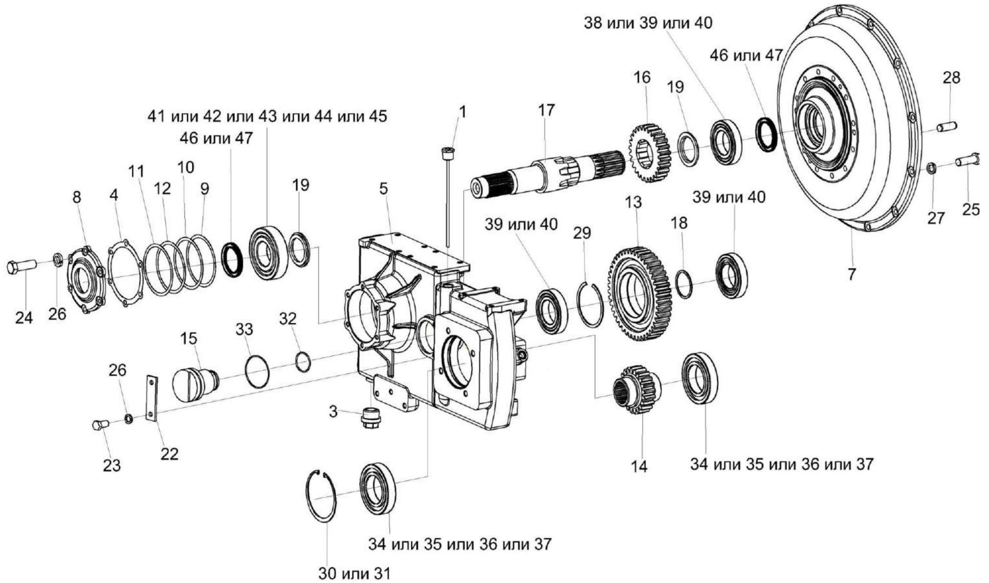
Рисунок 185 – Мультипликатор КЗК-12-0114100-08
