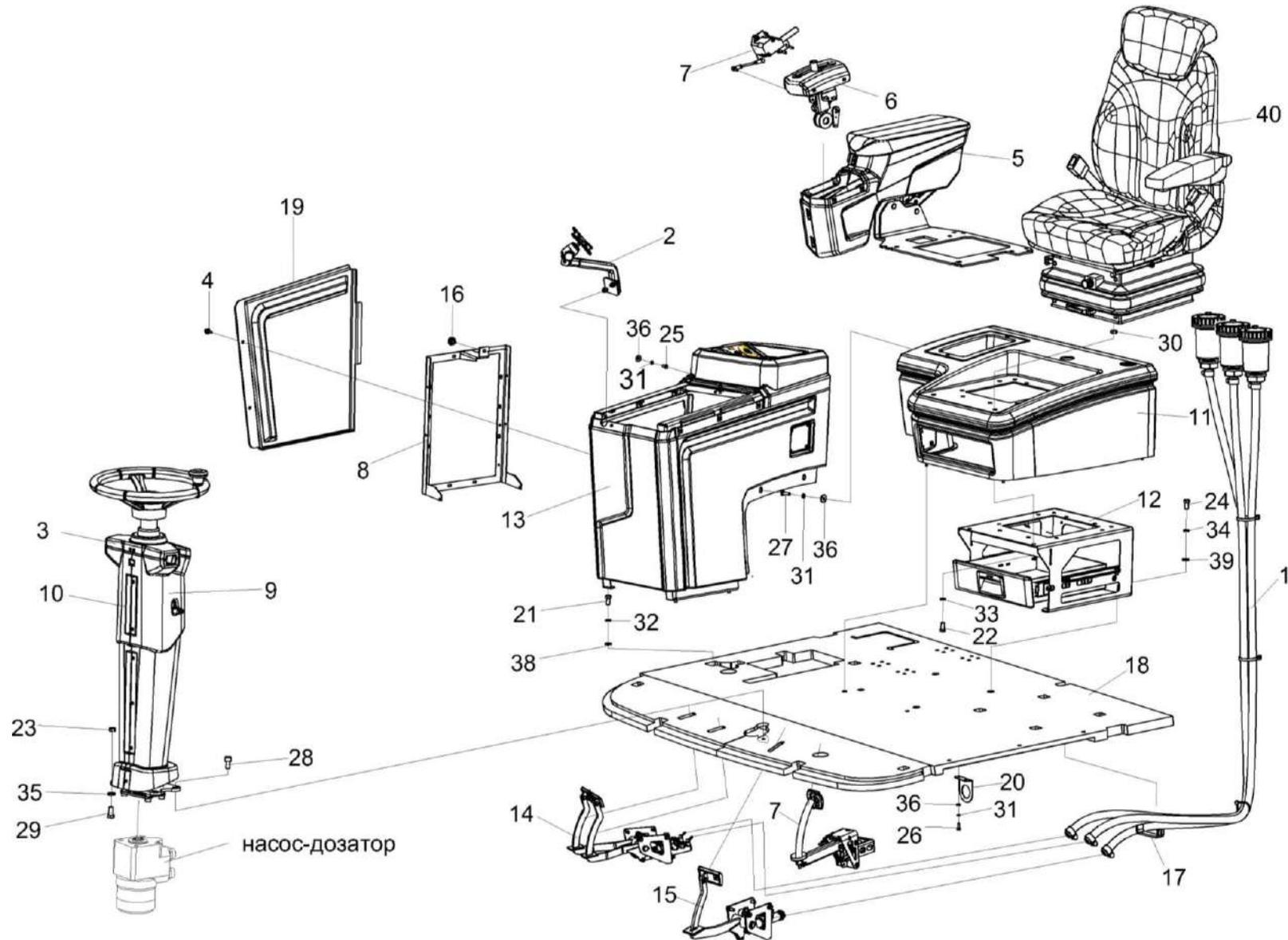
Рисунок 142 – Установка площадки управления УКЗ-01-0200000
