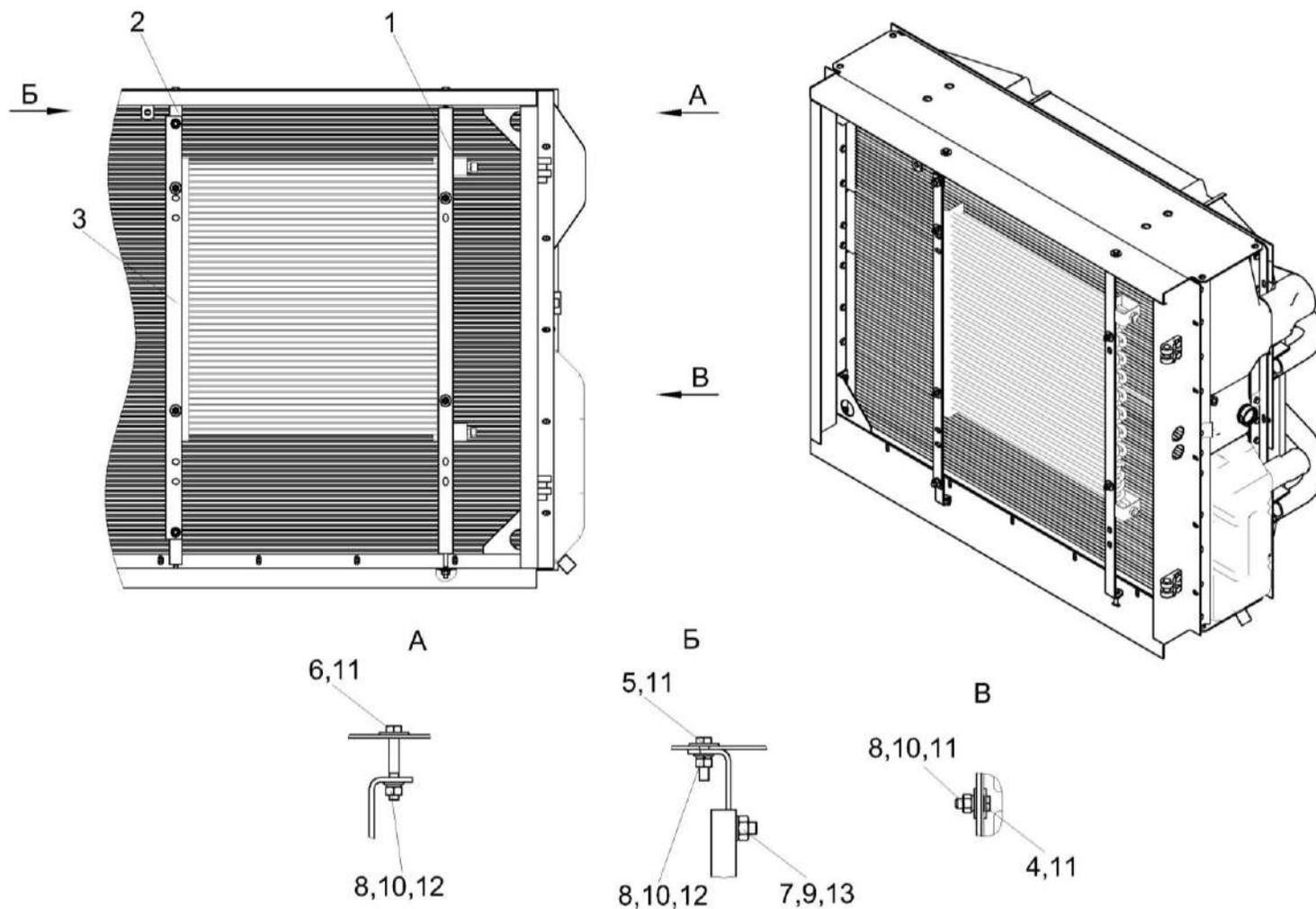
Рисунок 172 – Установка конденсатора КЗК-12-4-0113060
