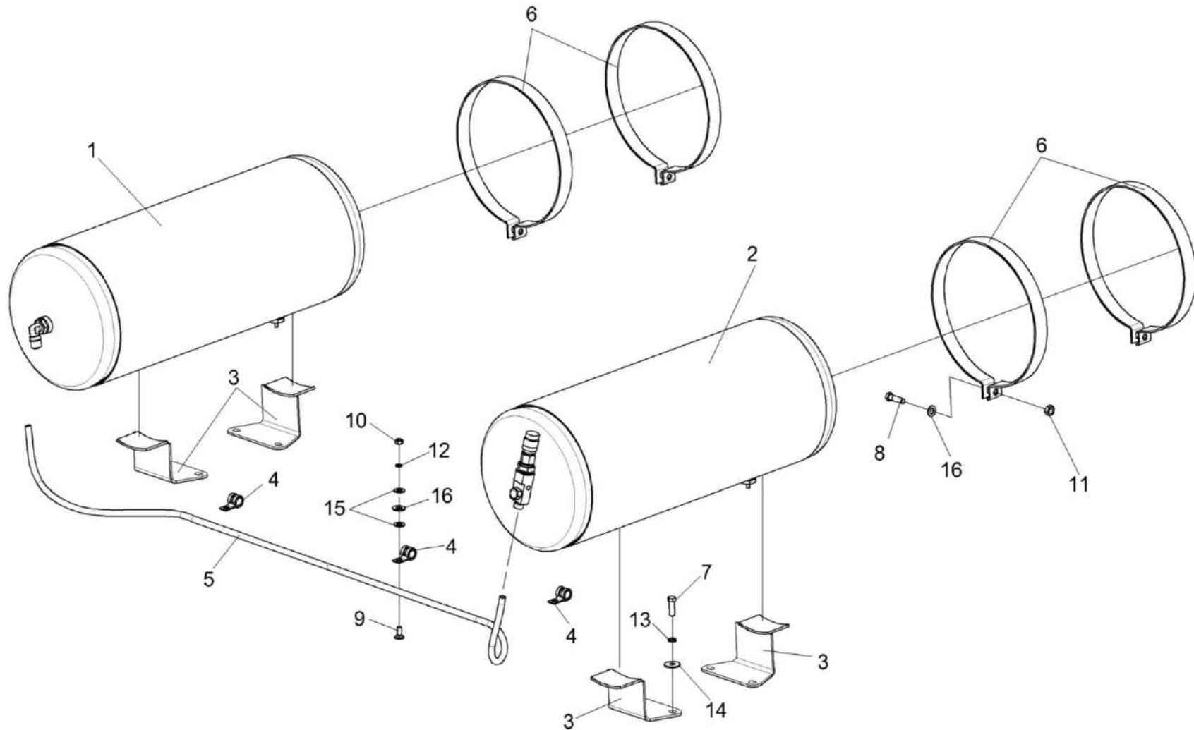
Рисунок 245 – Установка ресиверов КЗК-12А-10-1-0800010
