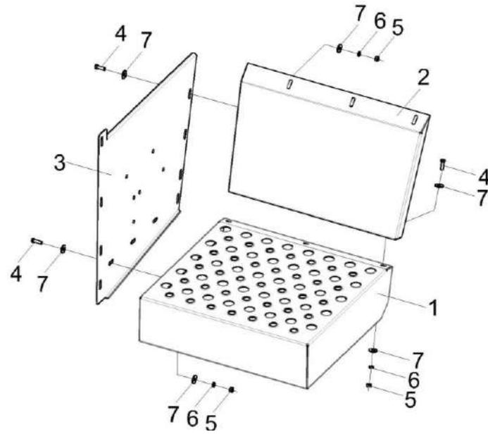
Рисунок 632 - Установка ступени КЗК-12-22-0128340
