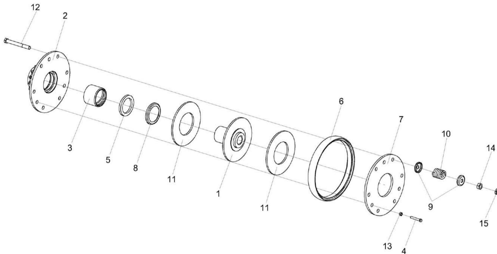
Рисунок 10 – Муфта фрикционная КЗК 0219020Б-01
