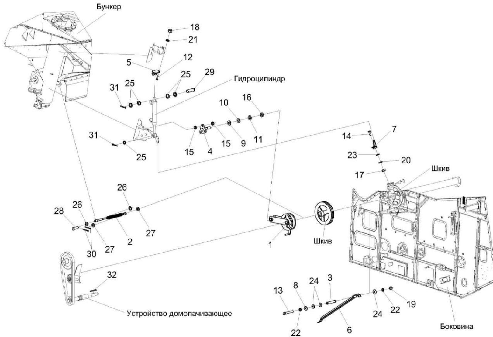
Рисунок 121 – Установка привода выгрузки КЗК-12А-1-0221100 (лист 1)
