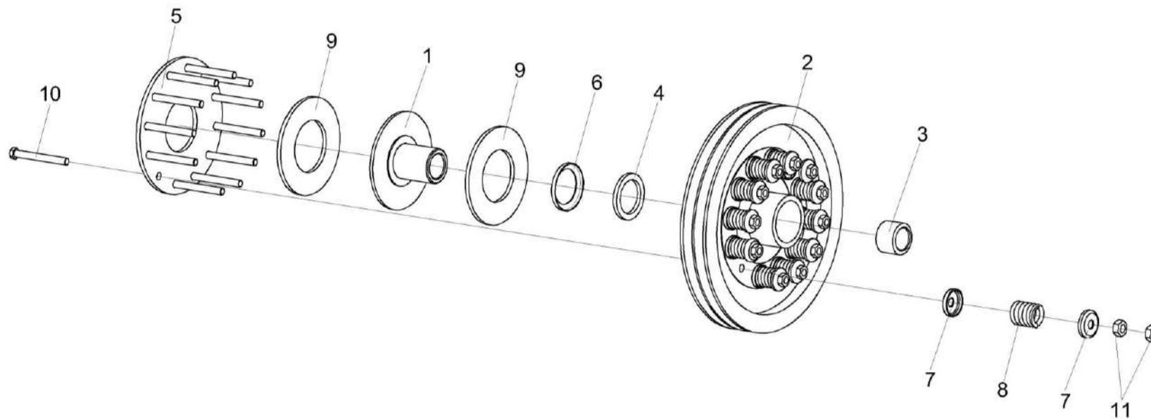
Рисунок 120 – Муфта фрикционная КЗК-10-0219100
