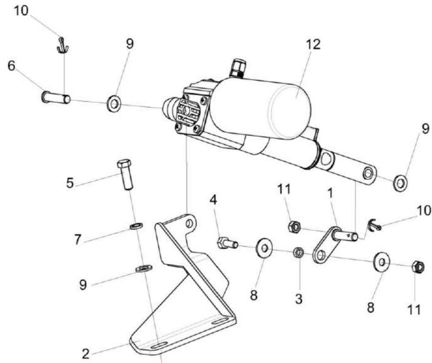
Рисунок 175 – Электромеханизм КЗК-12-22-0119670
