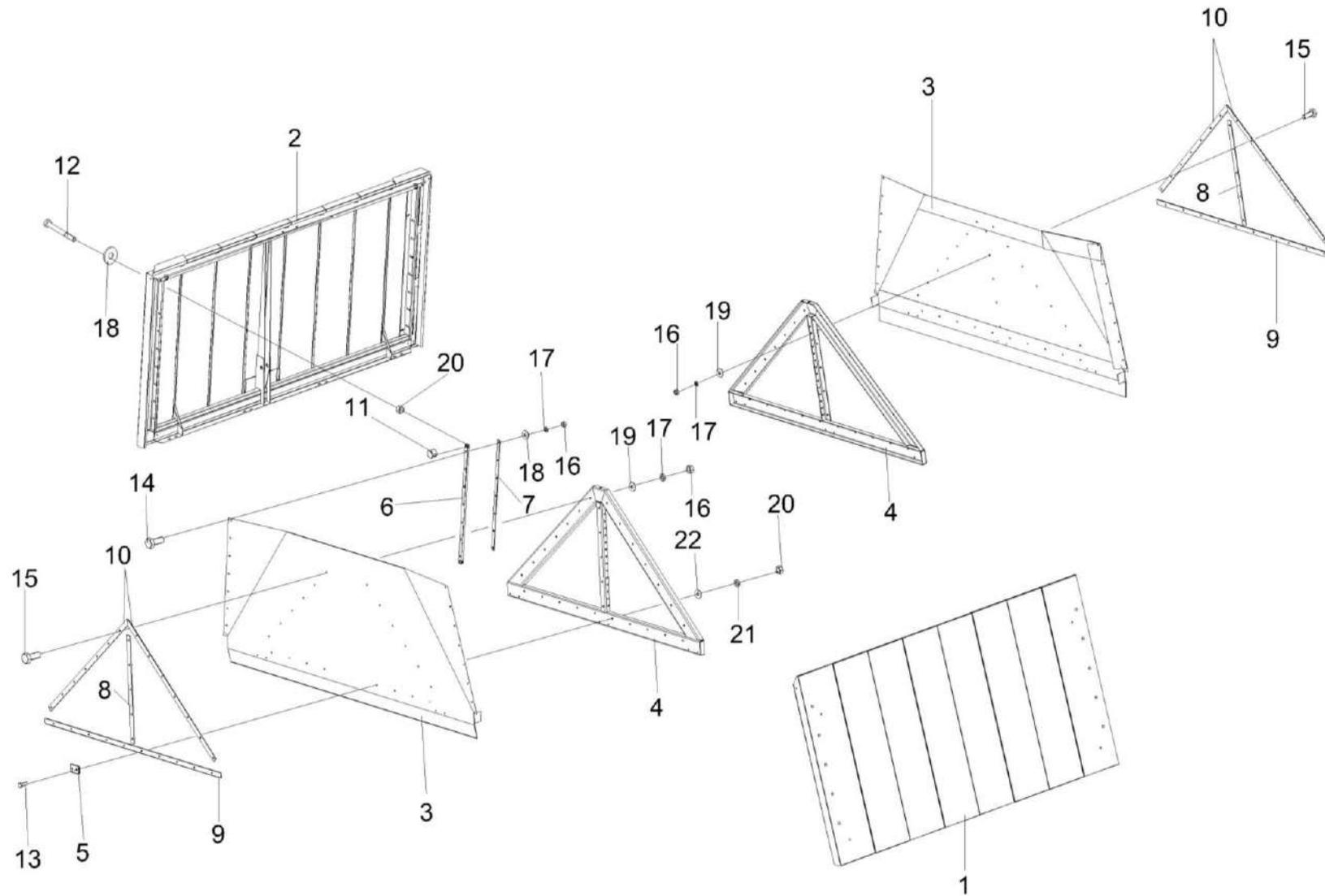
Рисунок 92 – Установка крыши бункера КЗК-3219-0134500
