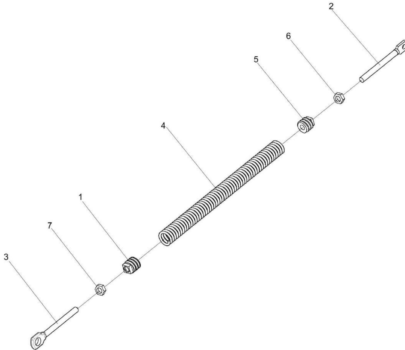
Рисунок 136 – Пружина КЗК-10-0290660
