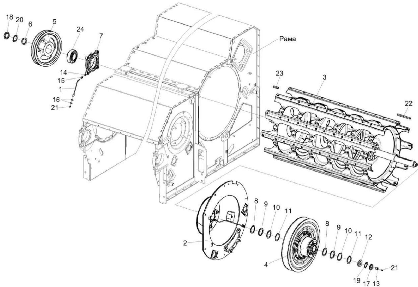
Рисунок 28 – Аппарат молотильный КЗК-12-22-1-0102000 (установка барабана молотильного)
