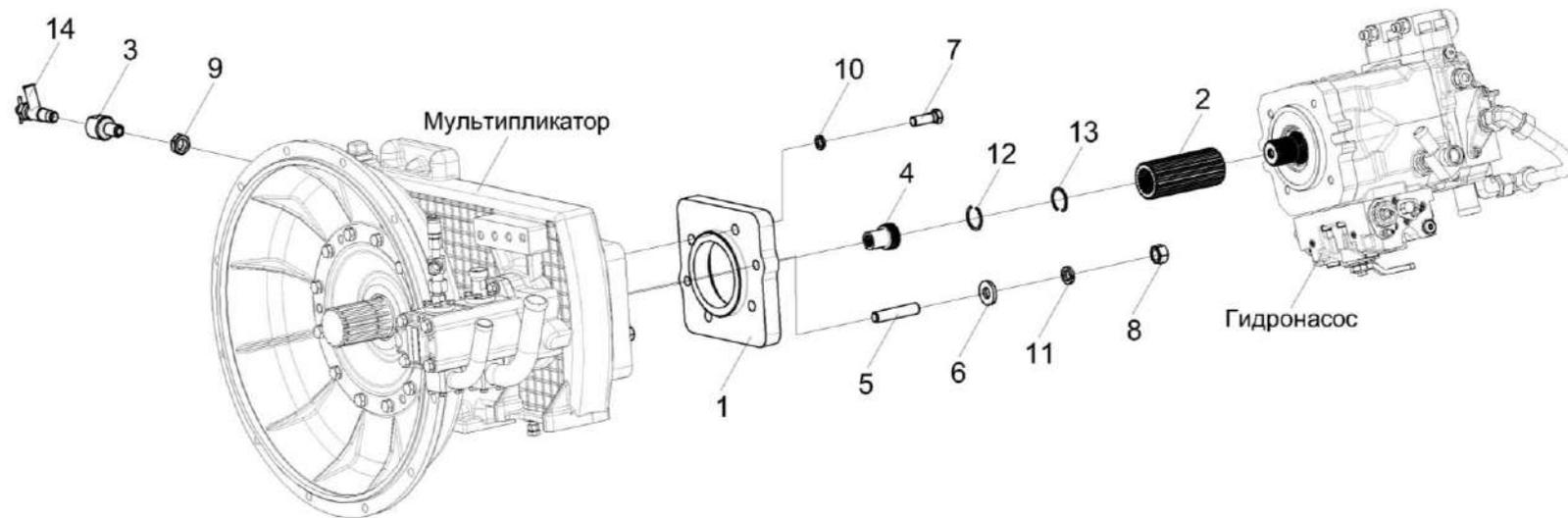
Рисунок 308 - Установка гидронасосов КЗК-8-9-0100200
