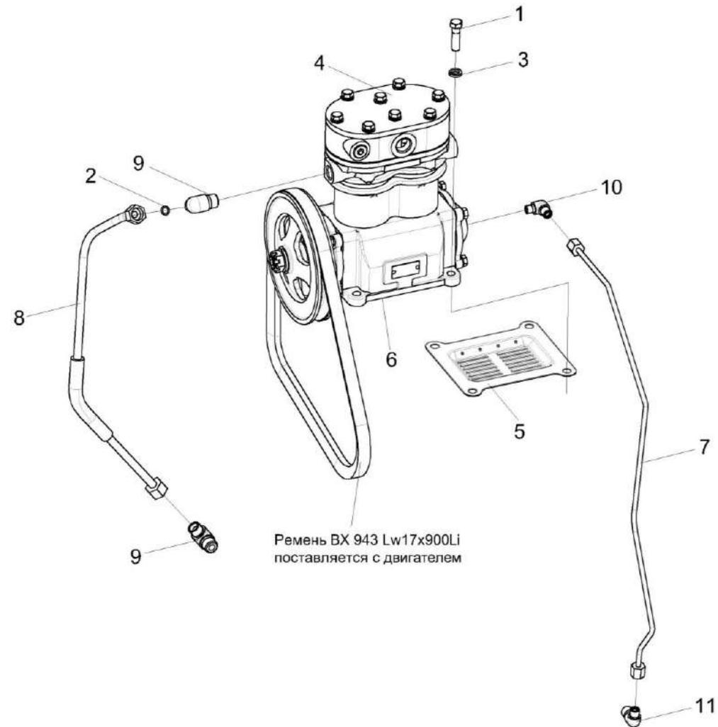
Рисунок 187 – Установка компрессора КЗК-12-3-0106800
