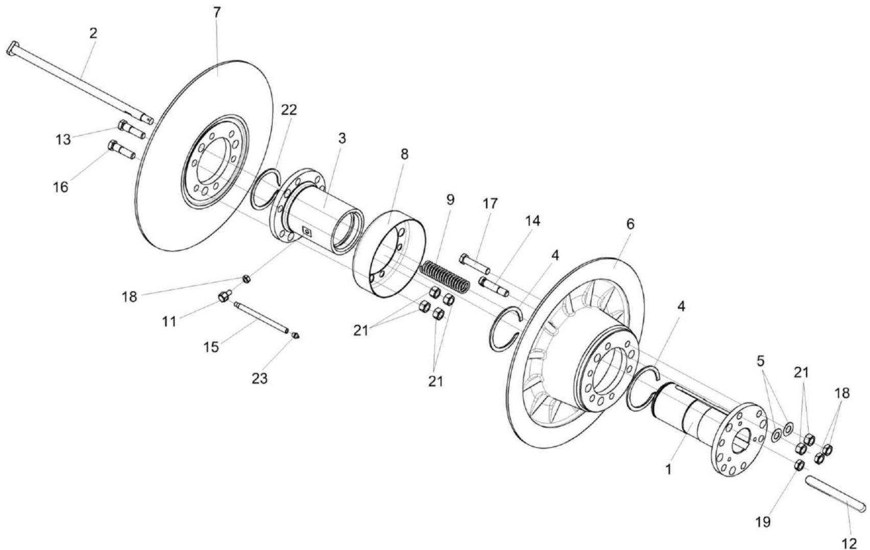
Рисунок 32 – Вариатор барабана КЗК 0108100-01 и КЗК 0108350-01
