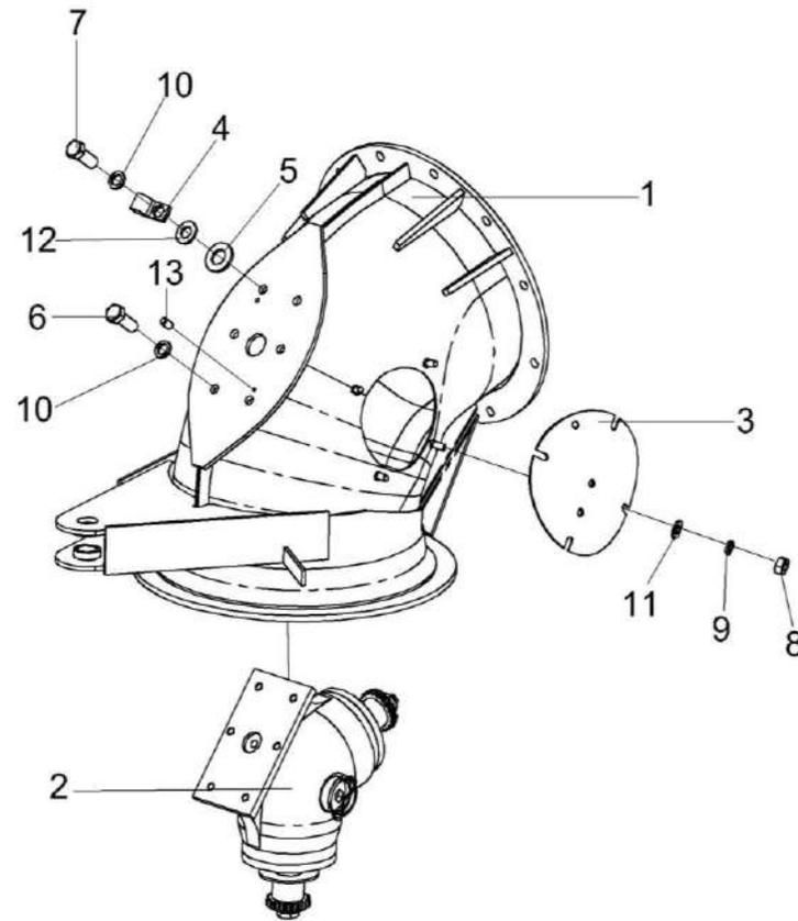
Рисунок 112 – Отвод с редуктором КЗК-810-0206020
