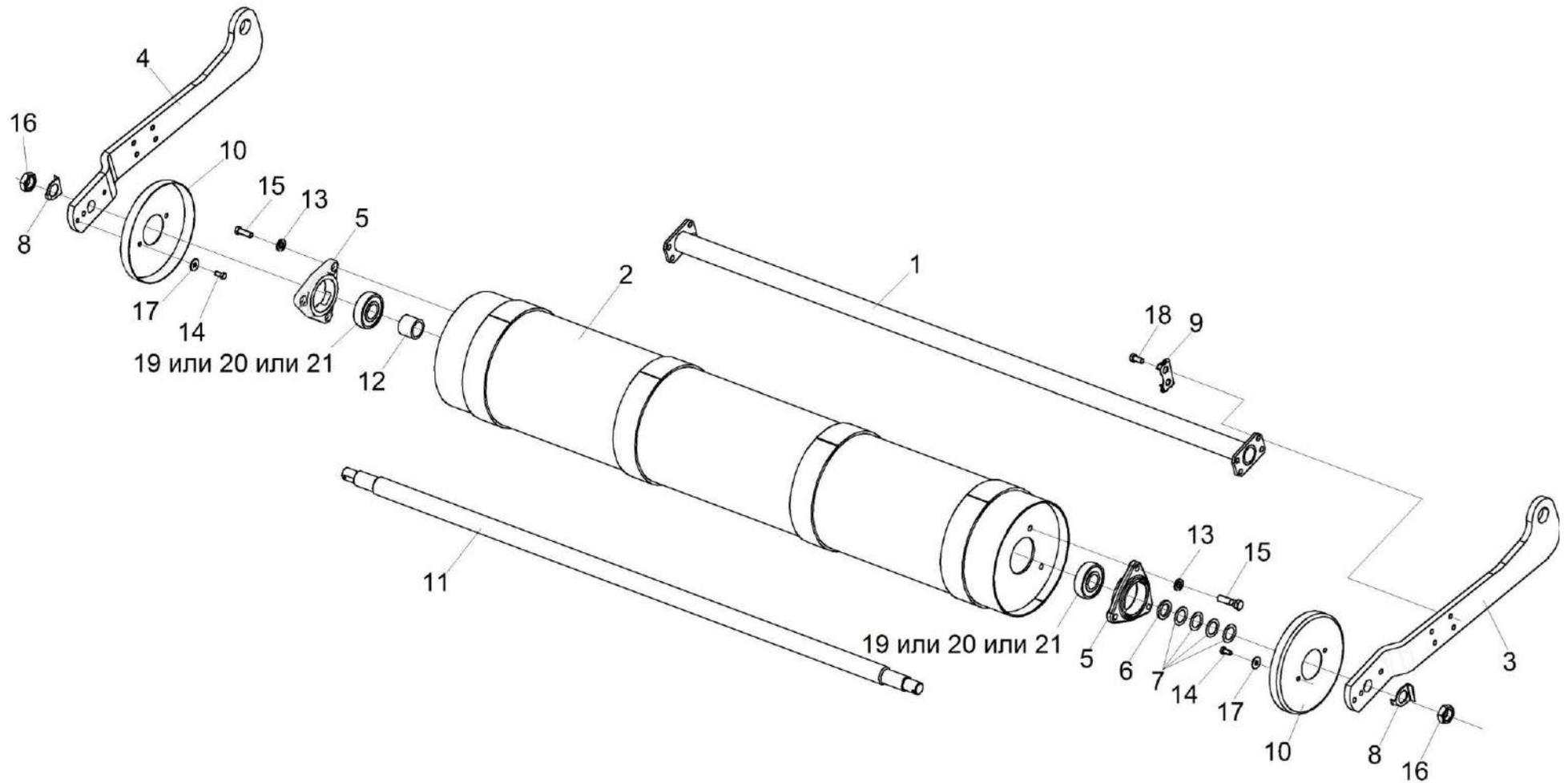
Рисунок 22 – Вал нижний КЗК-12-1836000Б
