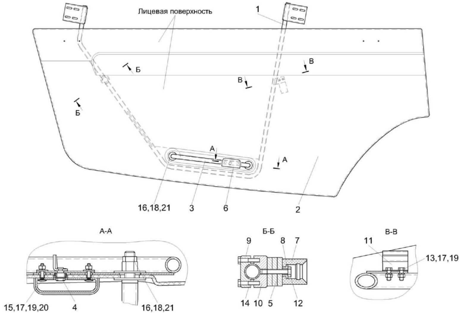
Рисунок 230 – Кожух боковой КЗК-12-15-0128030 и КЗК-12-15-0128030-01 (зеркальное отражение)
