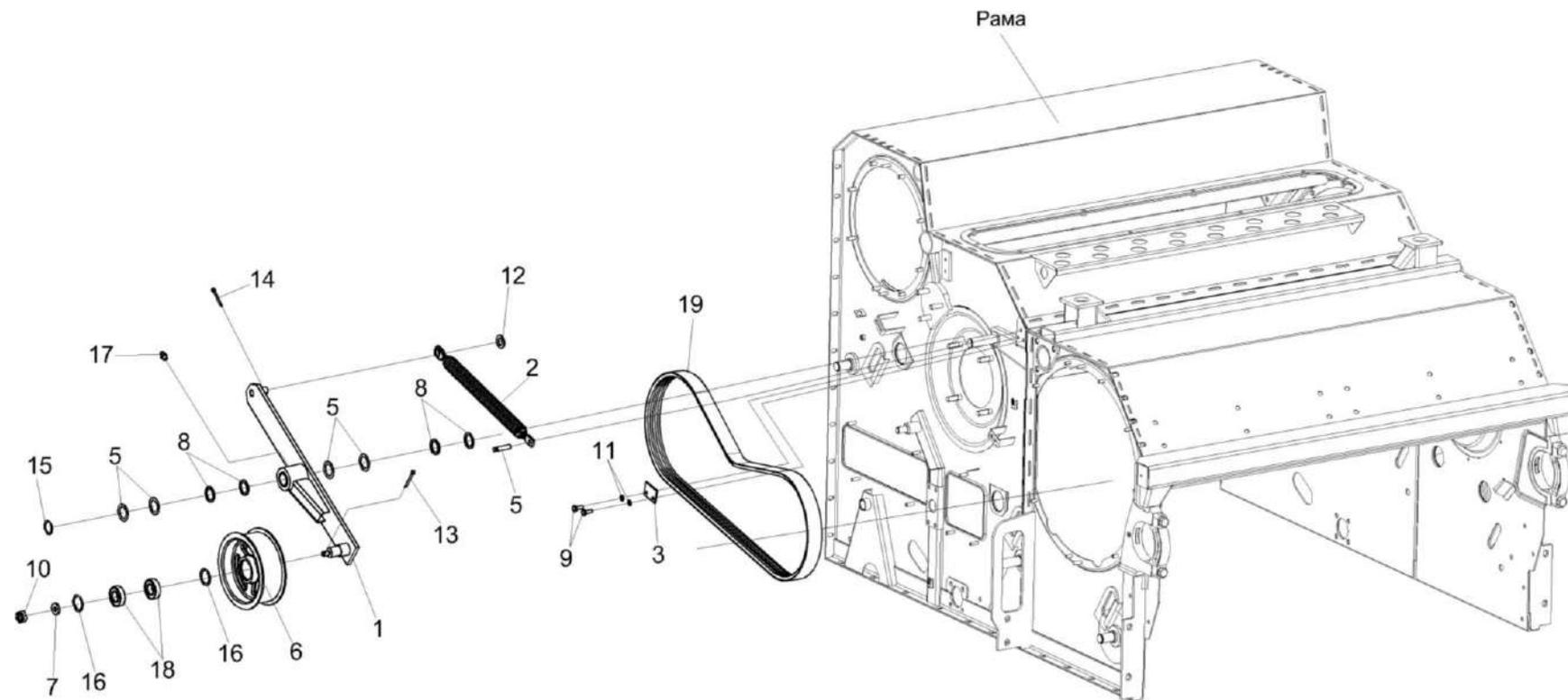
Рисунок 30 – Аппарат молотильный КЗК-12-22-1-0102000 (привод отбойного битера)
