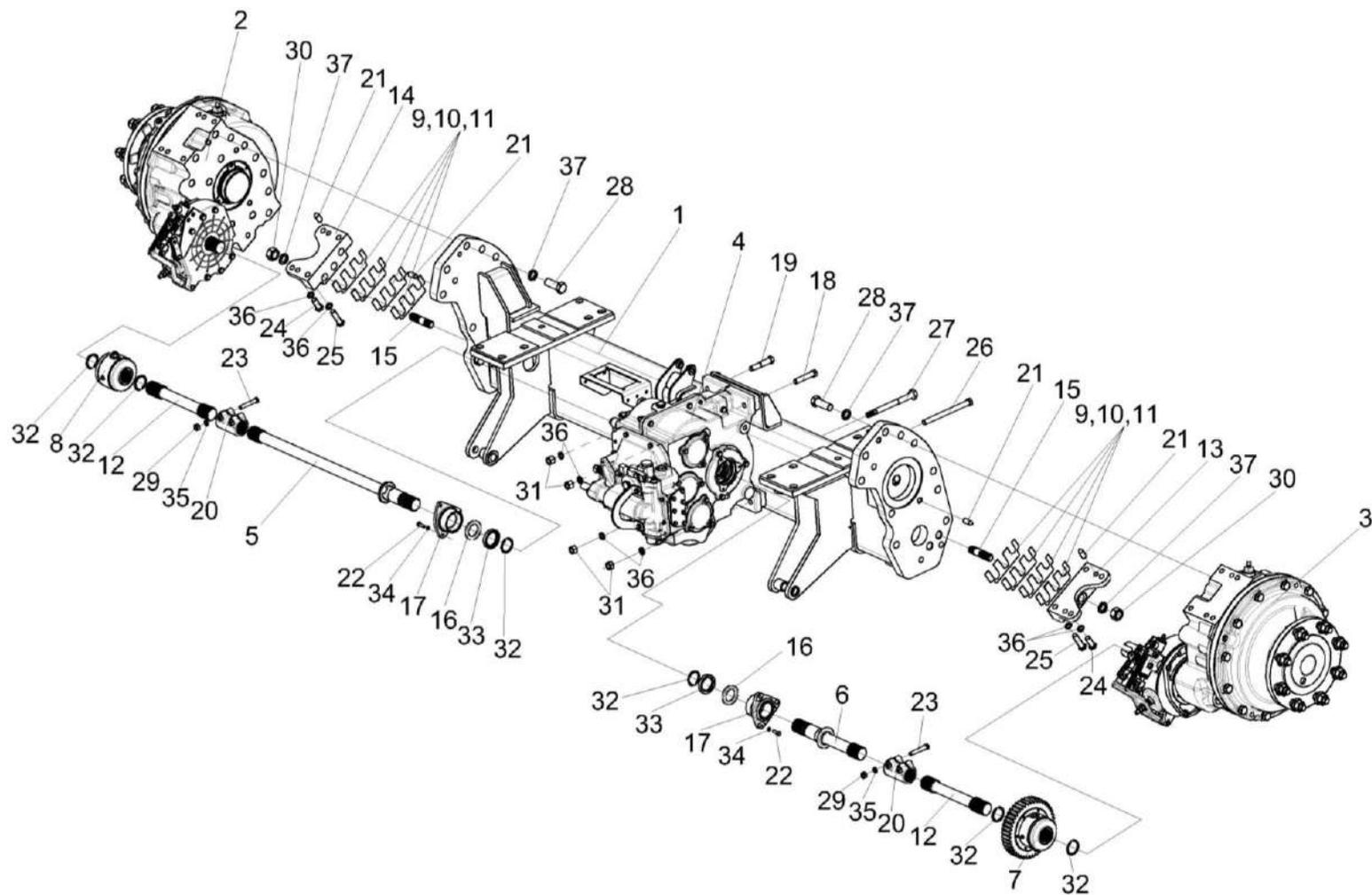
Рисунок 72 – Мост ведущих колес КЗК-12-0107500
