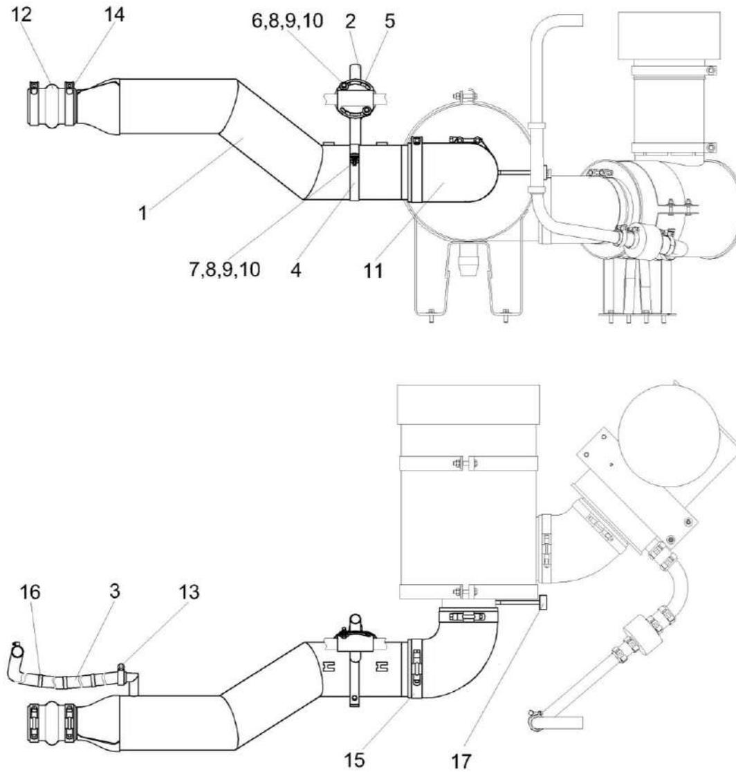
Рисунок 212 – Установка трубы воздушной КЗК-12-3-0126350А
