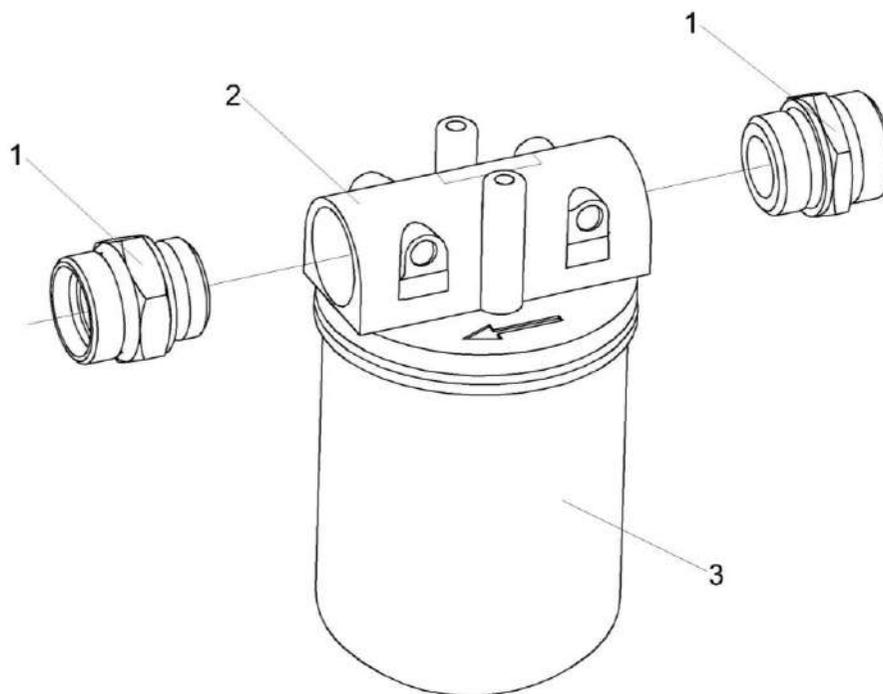
Рисунок 267 – Фильтр сливной КЗК-12-22-0602400
