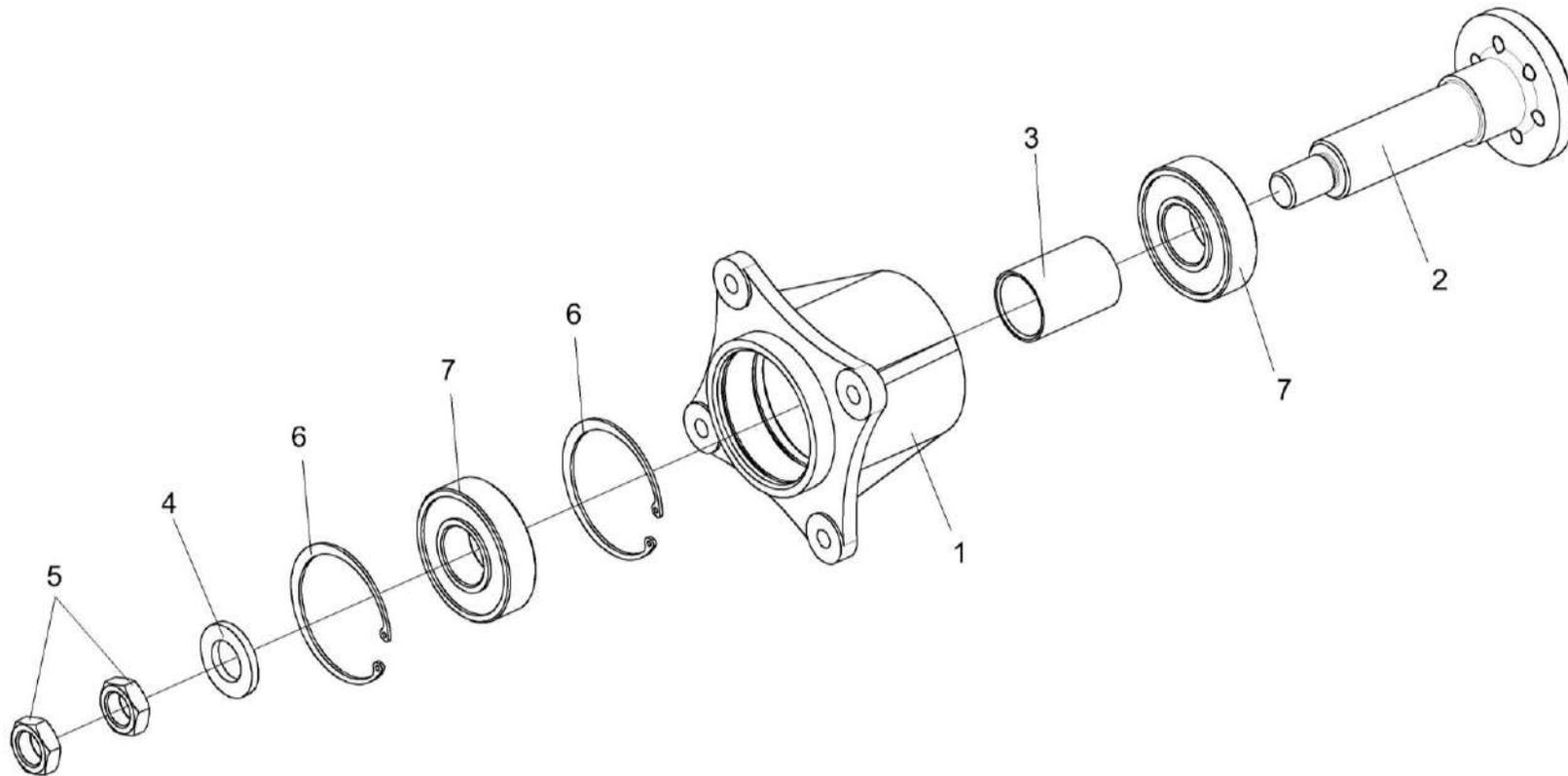
Рисунок 192 – Привод вентилятора КЗК 0106370А
