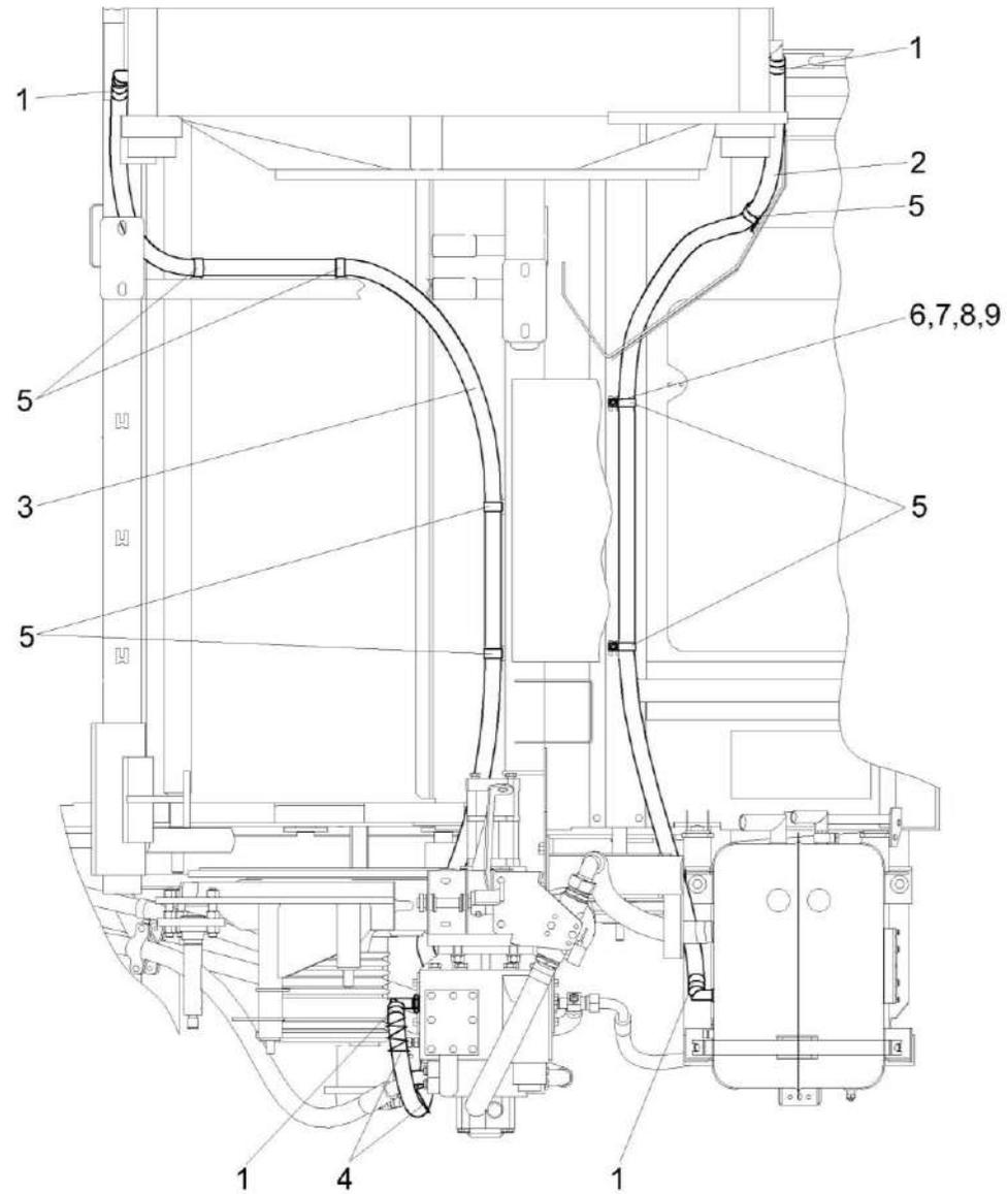
Рисунок 285 – Установка рукавов радиатора КЗК-12-0601700
