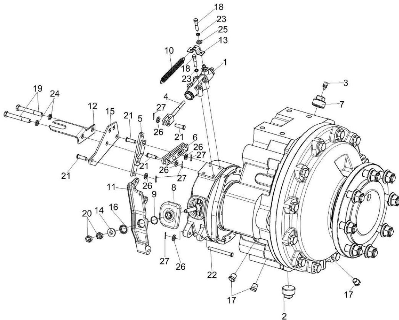
Рисунок 75 – Редуктор бортовой КЗК-10-0107200-04 (лист 1)
