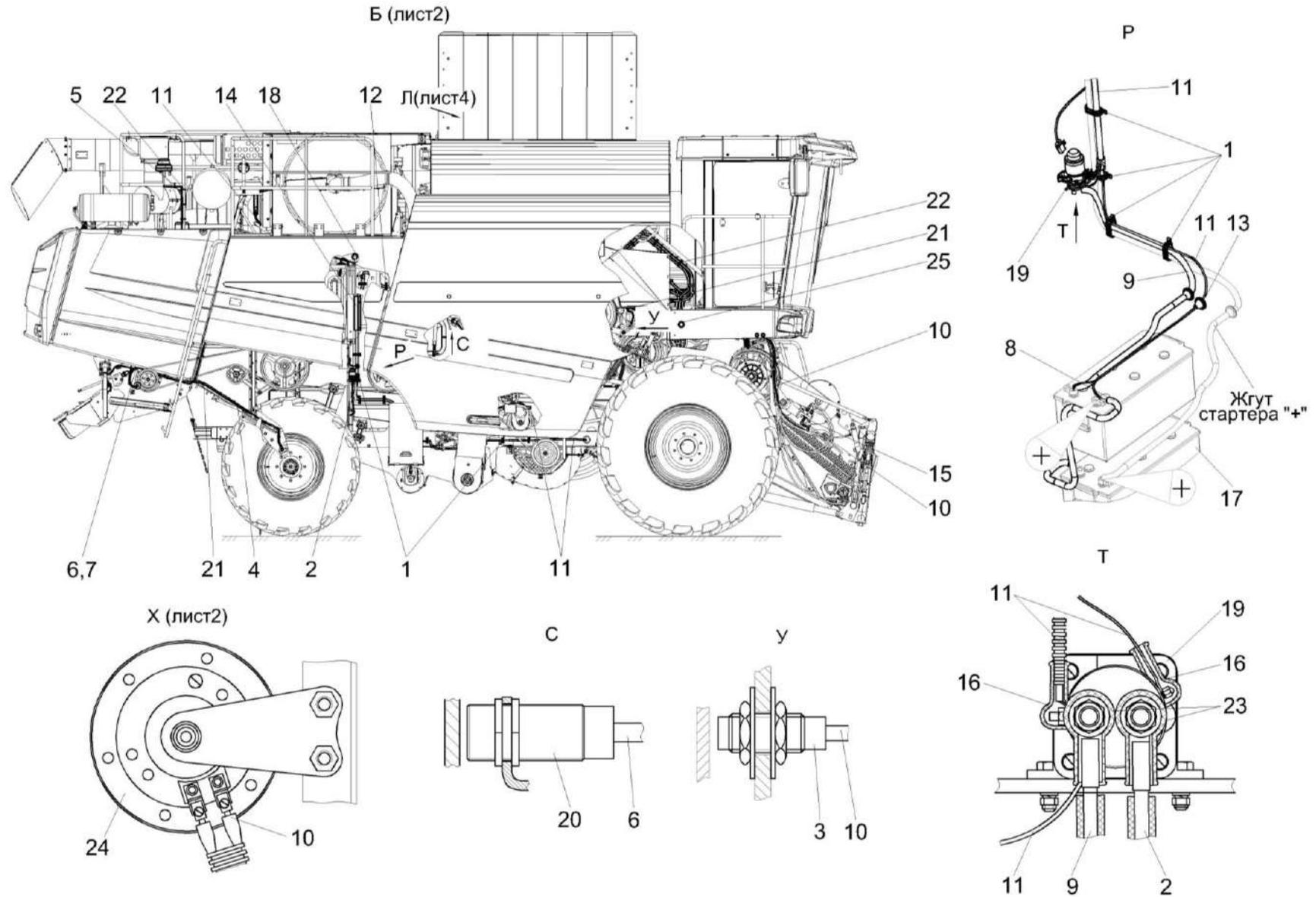
Рисунок 289 - Установка электрооборудования молотилки КЗК-12-23-0721000 (лист 3)
