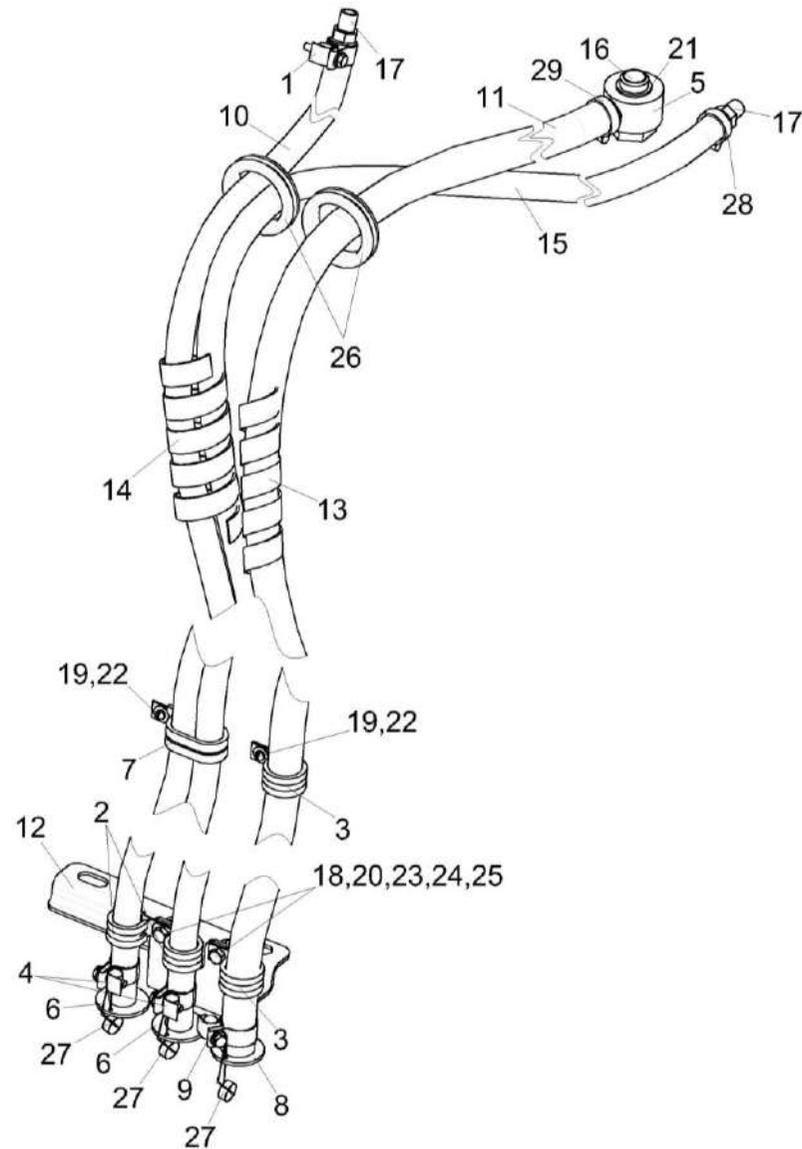
Рисунок 195 – Установка сливного рукава КЗК-8-9-0106490
