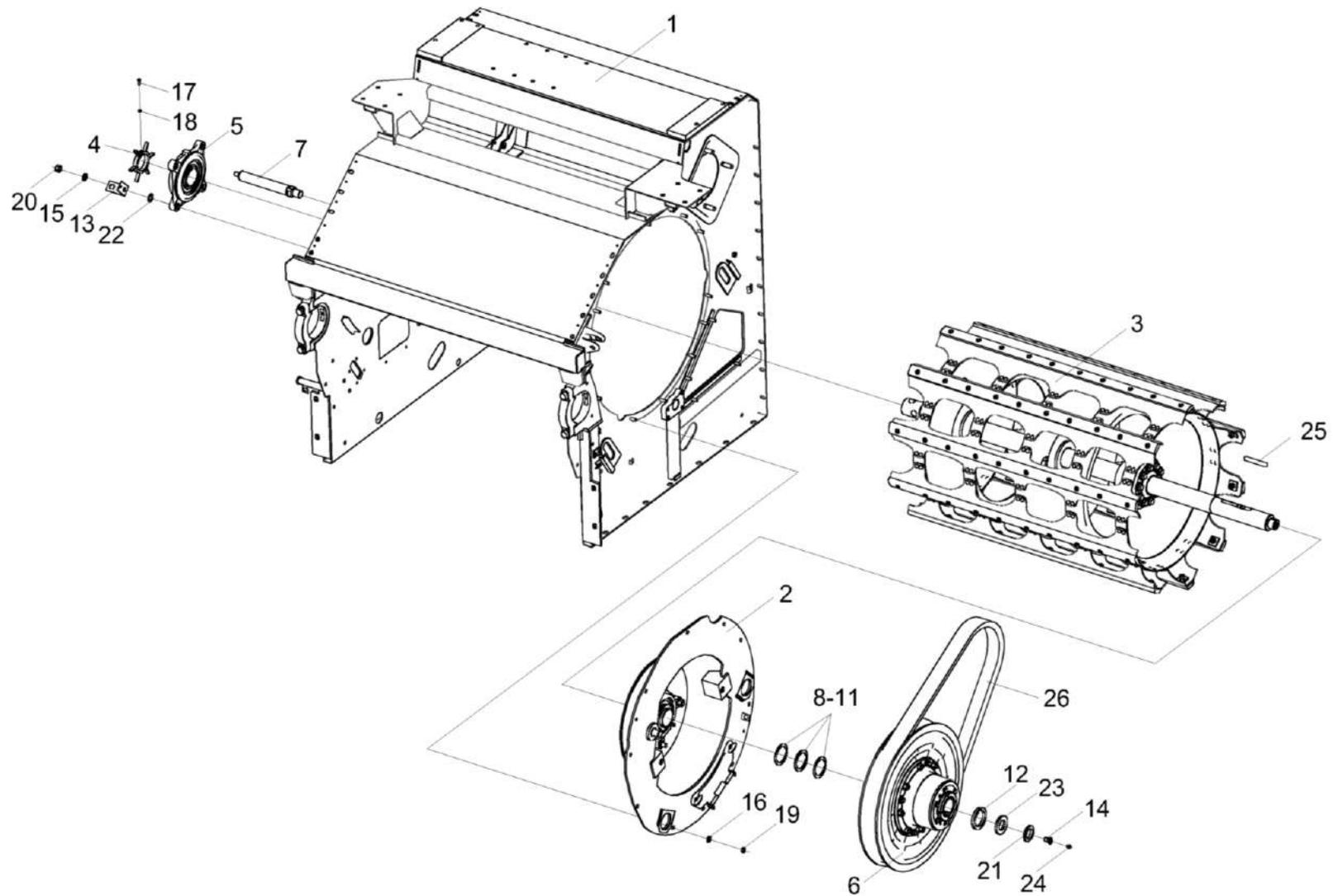
Рисунок 15 - Аппарат молотильный КЗК-8-9-1-0102000 (установка барабана молотильного)
