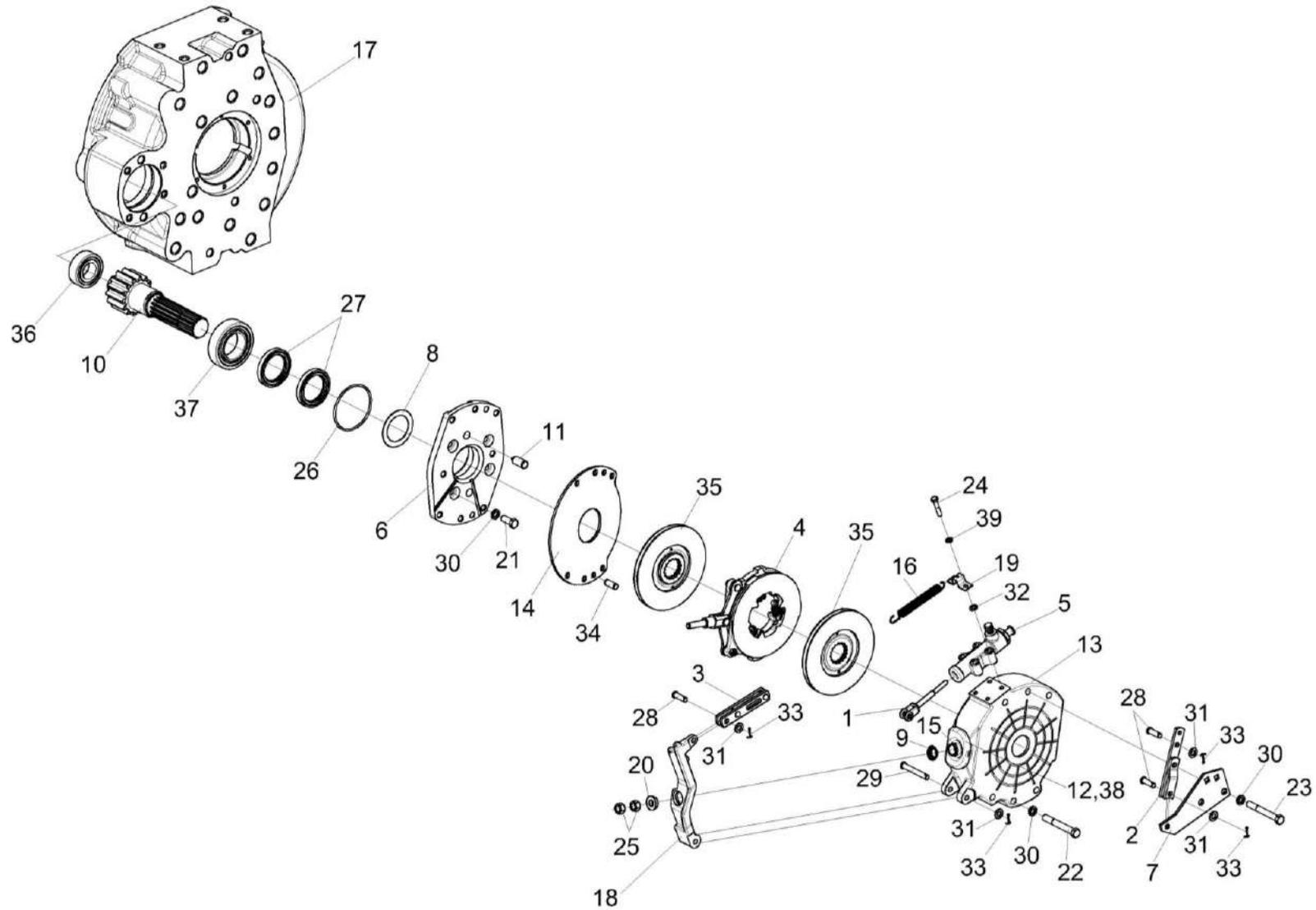
Рисунок 33 – Редуктор бортовой КЗК-400-1-0107020 и КЗК-400-1-0107020-01 (лист 2)
