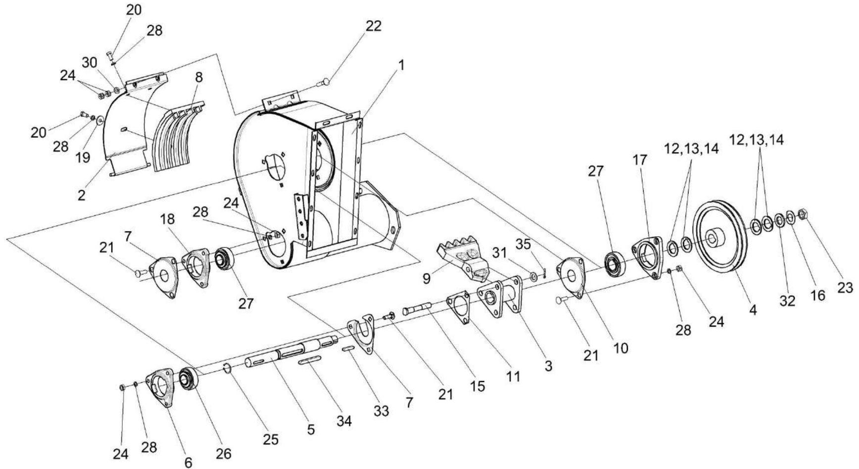
Рисунок 63 – Устройство домолачивающее КЗК 0207000В
