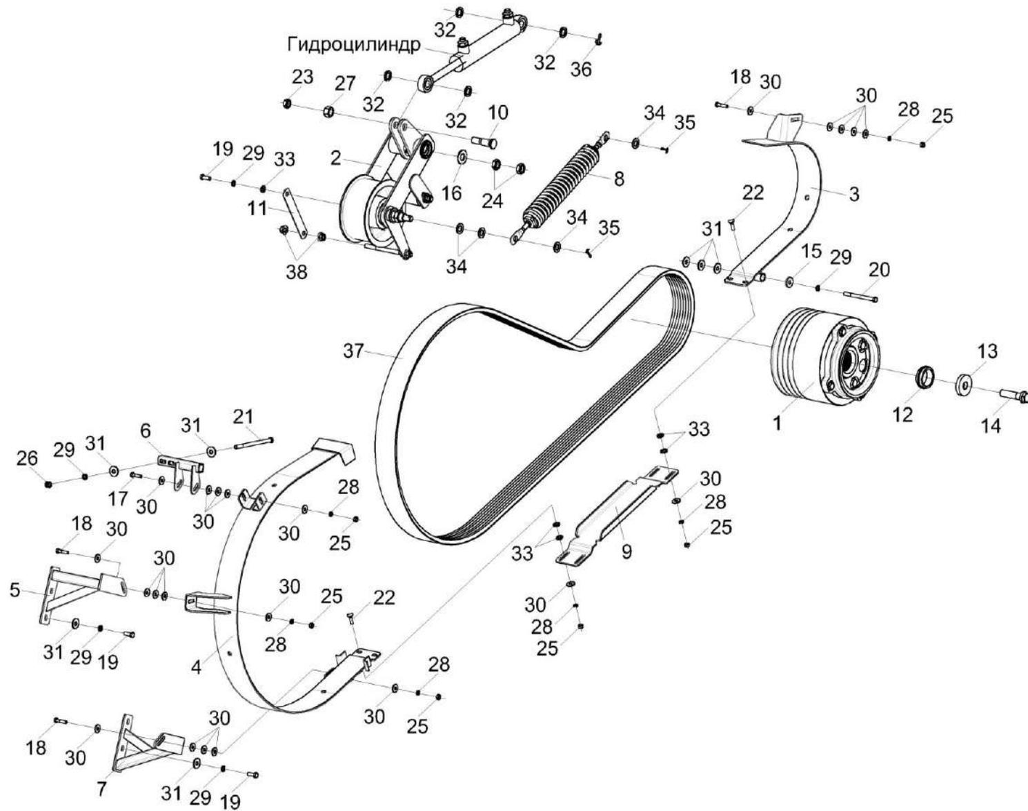
Рисунок 206 - Привод главного контрпривода КЗК-8-9-0220000
