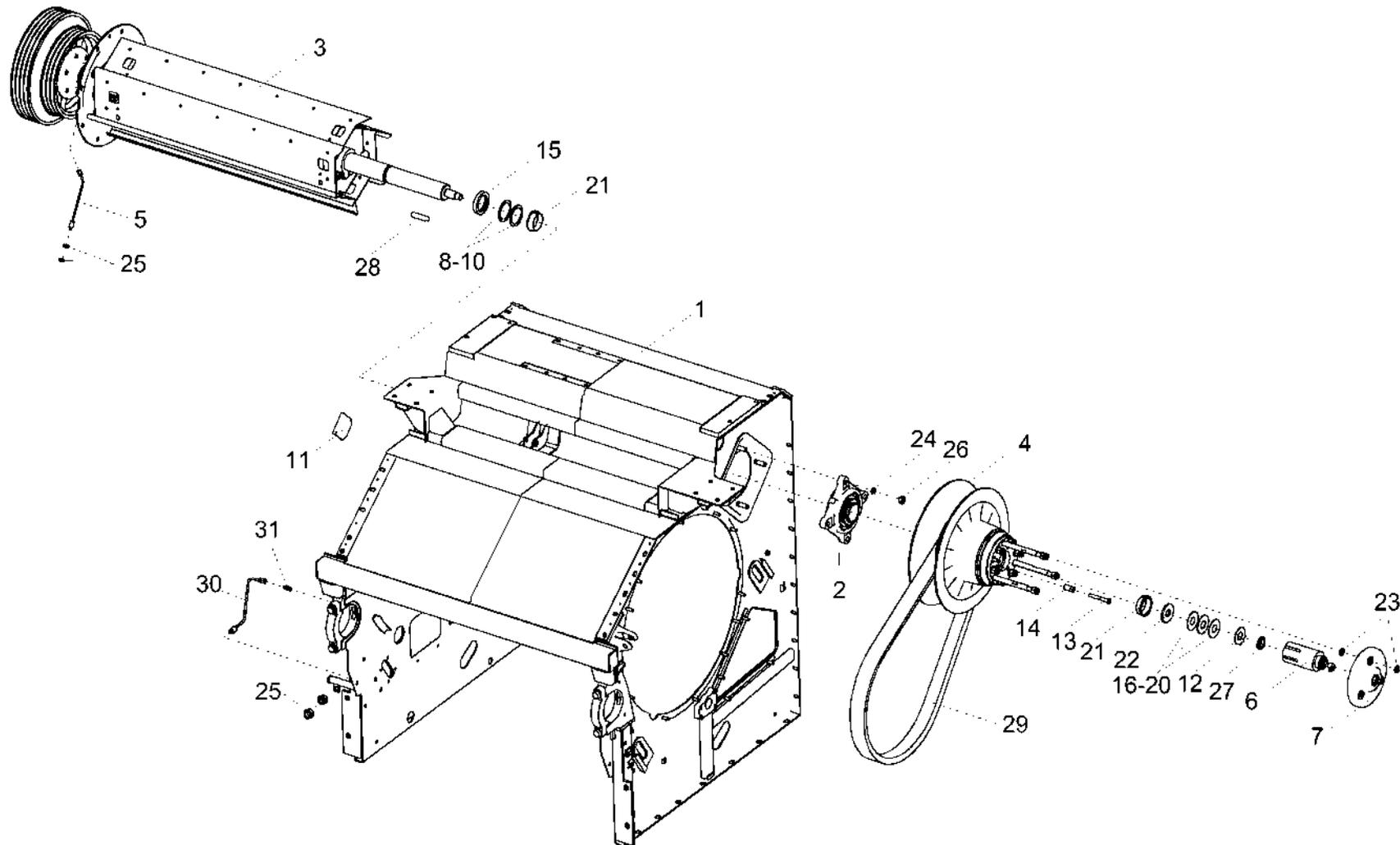
Рисунок 11 - Аппарат молотильный КЗК-8-9-1-0102000 (установка битера отбойного)
