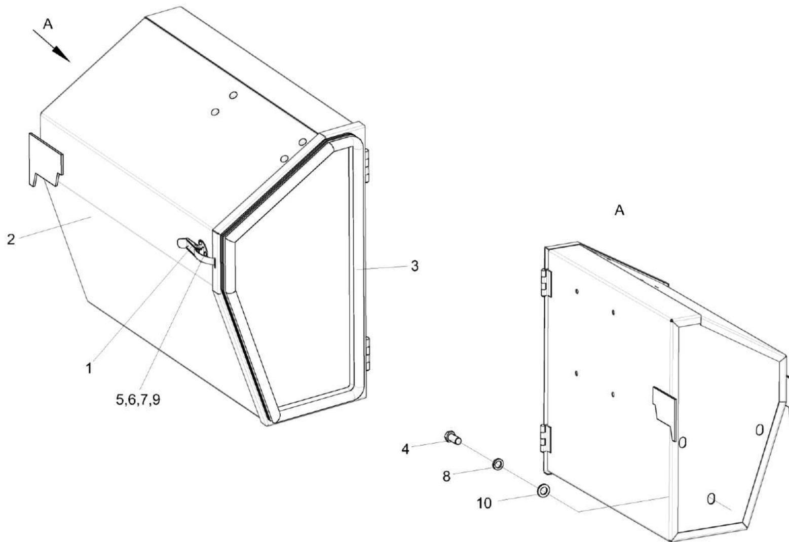
Рисунок 227 – Ящик инструментальный КЗК-12-0130000А-01
