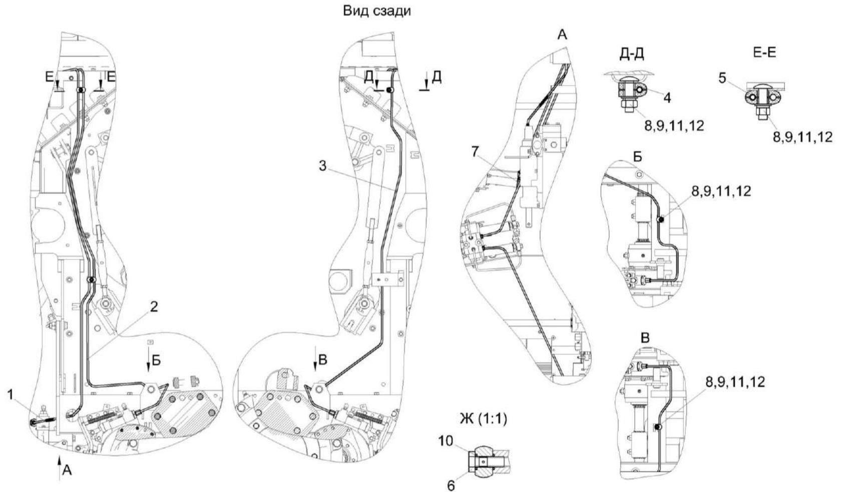
Рисунок 176 – Установка тормозных трубопроводов КЗК-8-9-0119630
