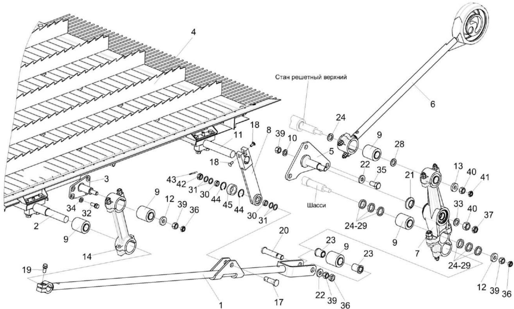
Рисунок 70 – Установка привода доски стрясной КЗК 0280000А (вид слева)
