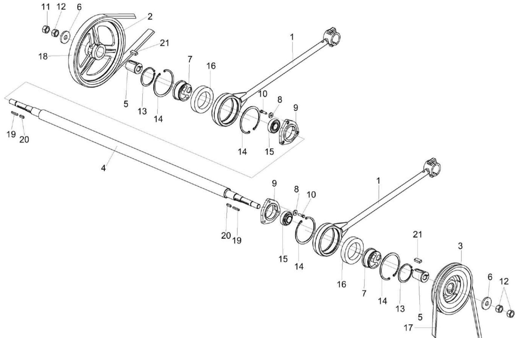
Рисунок 69 – Установка шатуна КЗР 0202030Е и шкивов КЗК-5-4-0202120, КЗК-8А-0202111
