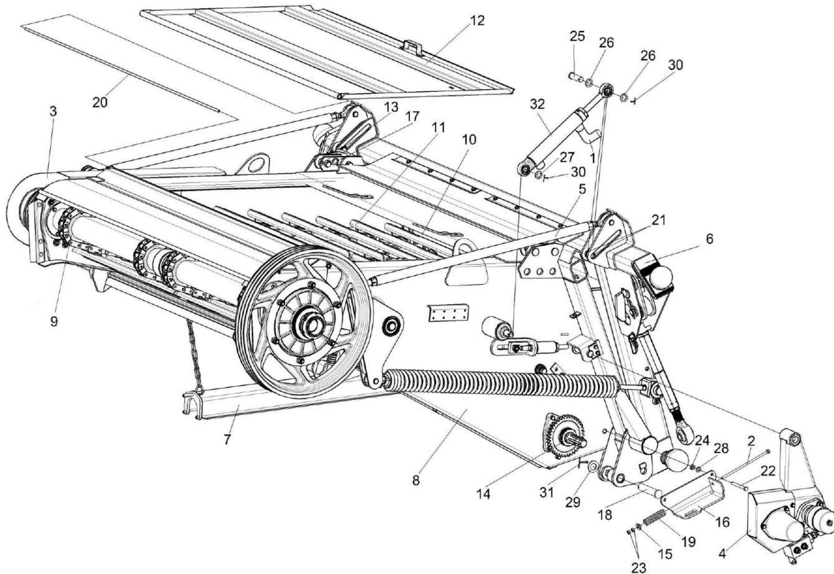
Рисунок 2 – Камера наклонная КЗК-8-8-1800000
