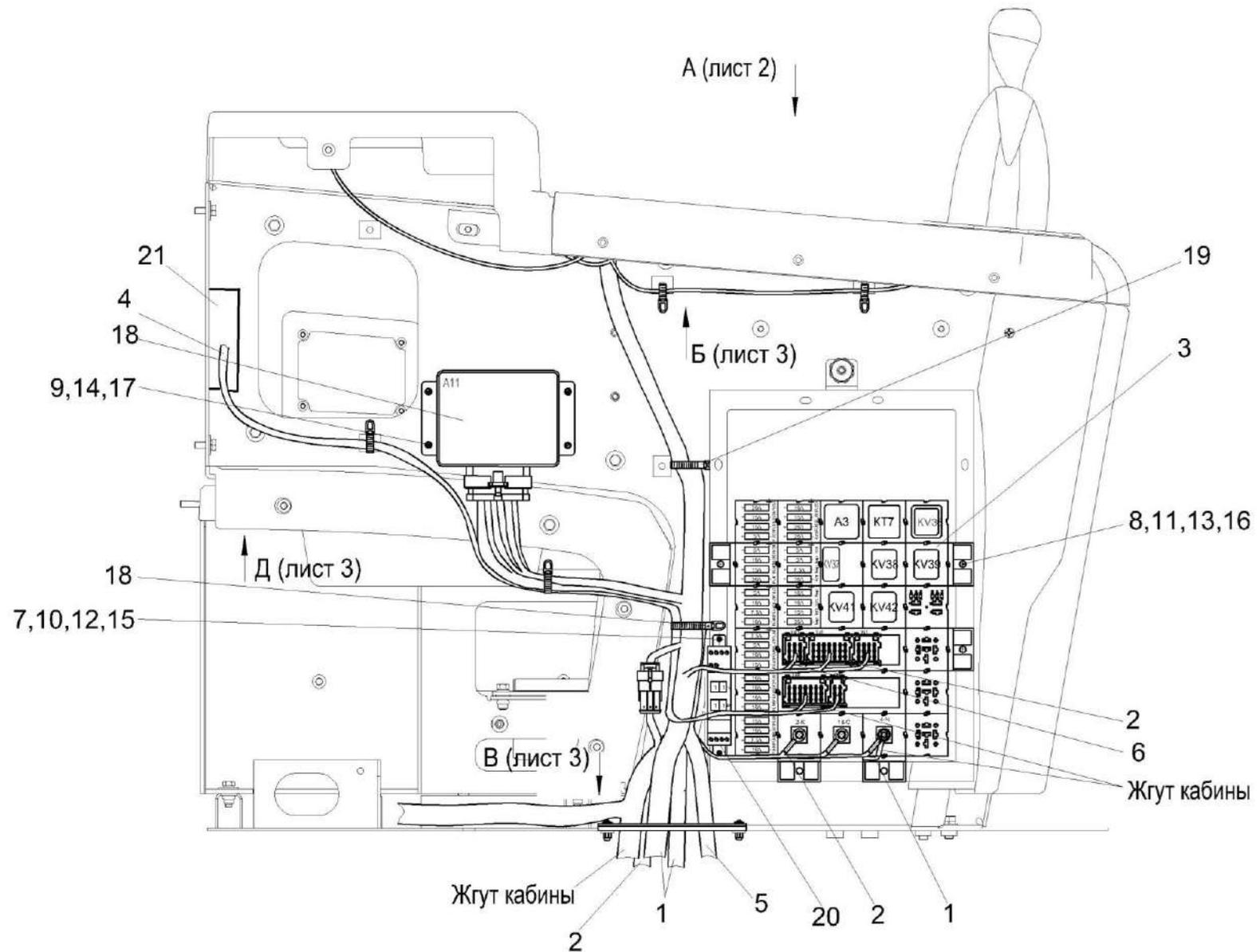
Рисунок 256 – Установка электрооборудования пульта управления КЗК-400-1-0725000 (лист 1)
