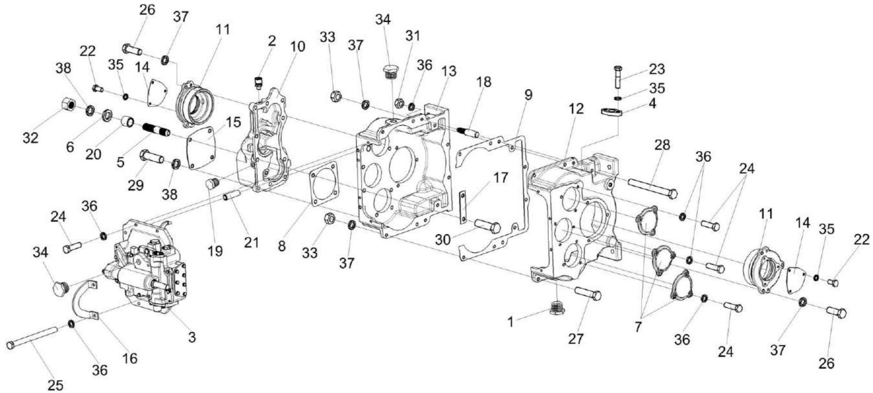
Рисунок 38 – Коробка передач КЗК-8-4-0107030 (корпус, крышки)
