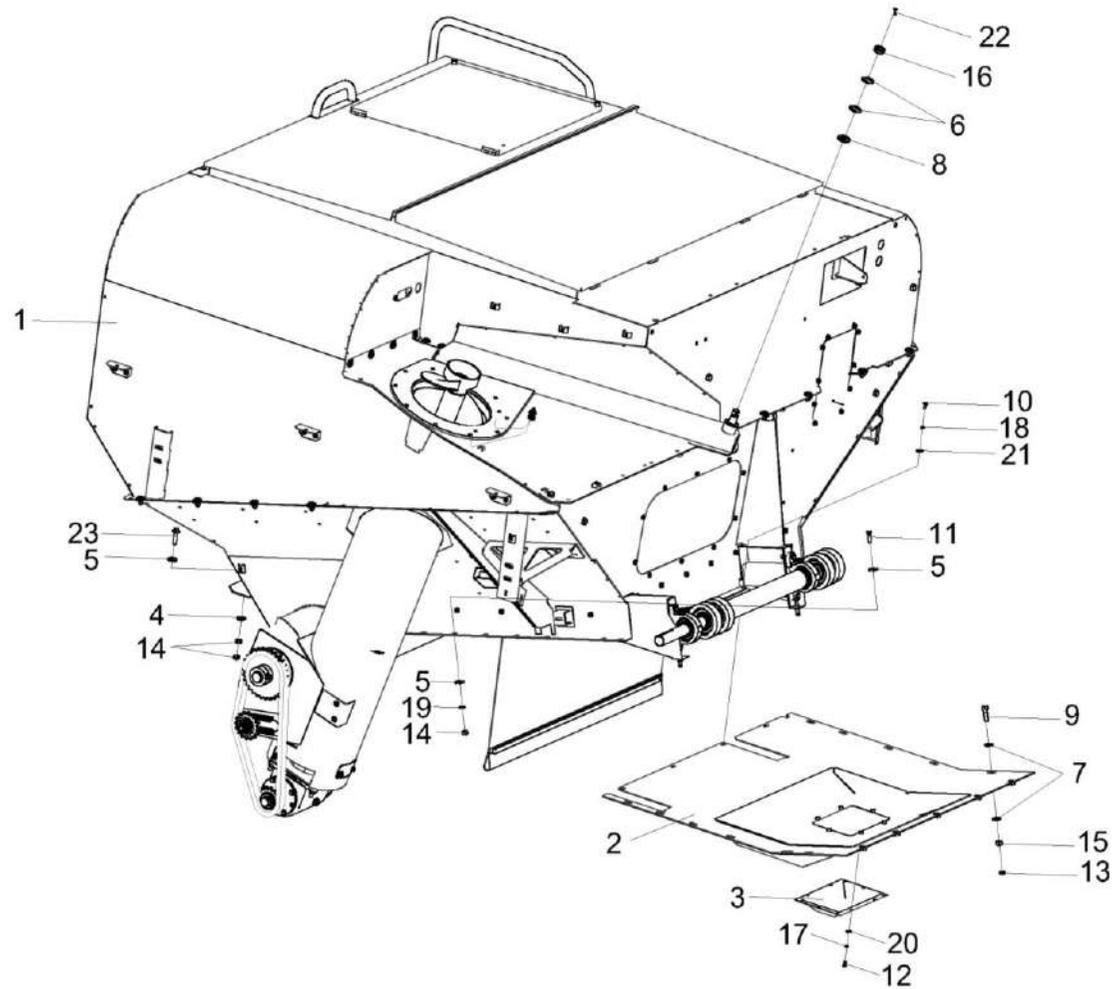
Рисунок 79 - Установка бункера КЗК-8-9-0203000
