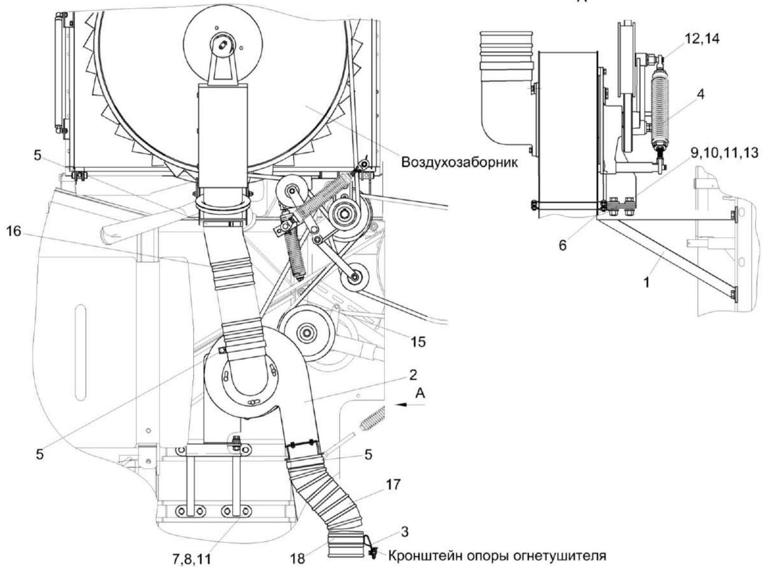
Рисунок 204 – Установка вентилятора КЗК-8А-0112100
