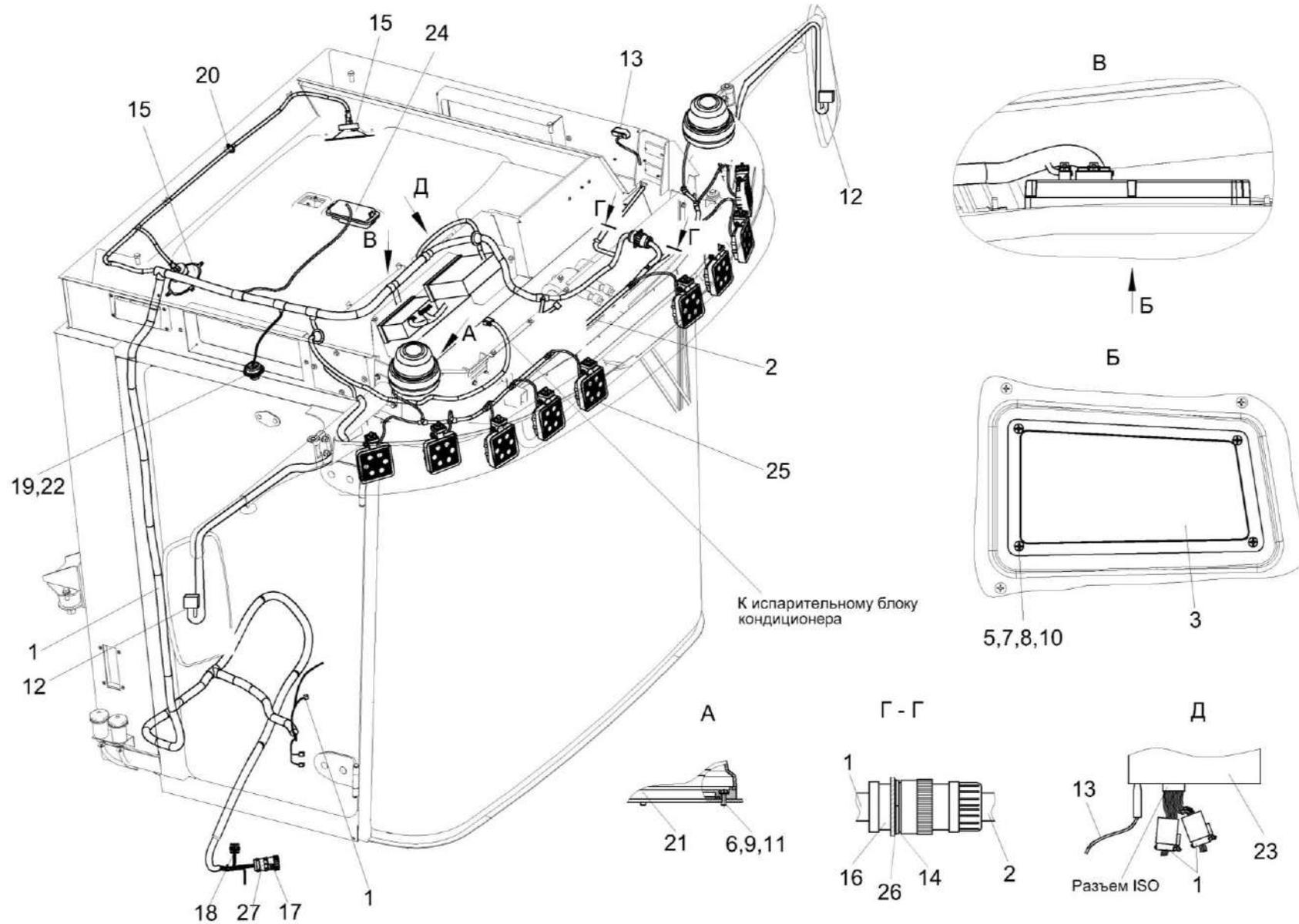
Рисунок 261 – Установка электрооборудования кабины КЗК-8-9-0722000
