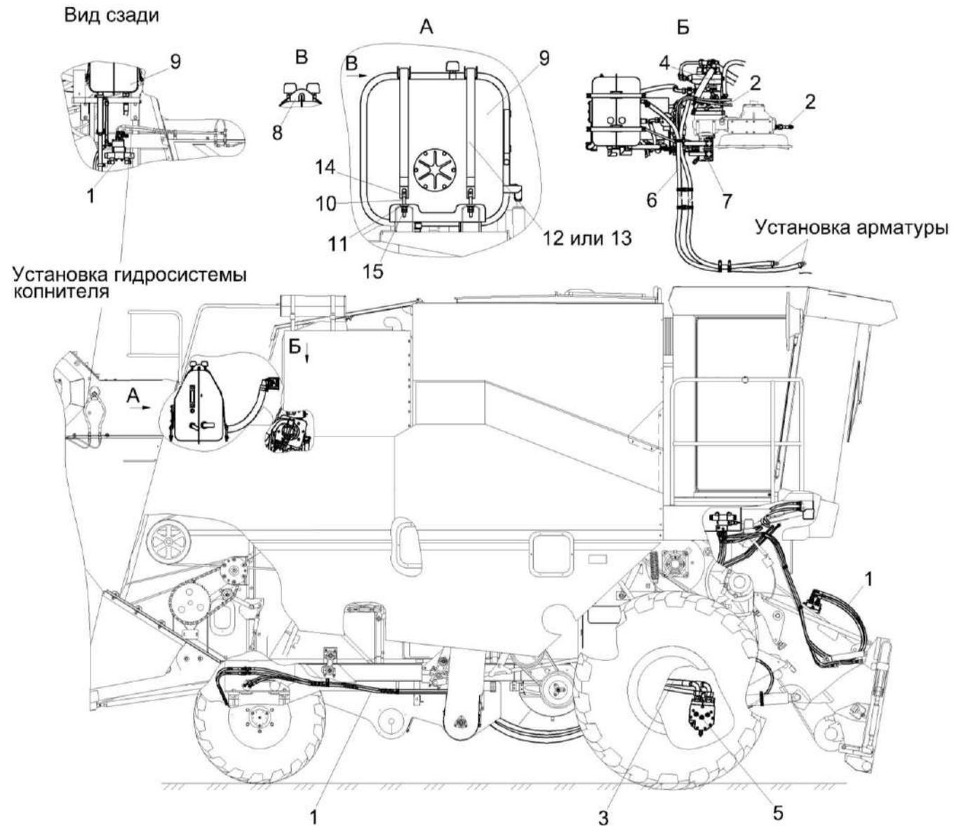
Рисунок 264 – Гидросистема КЗК-400-1-0600000
