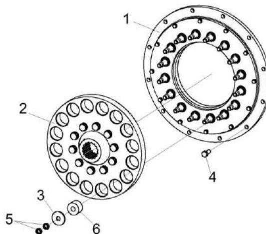
Рисунок 184 – Установка муфты КЗК-10-2-0106050
