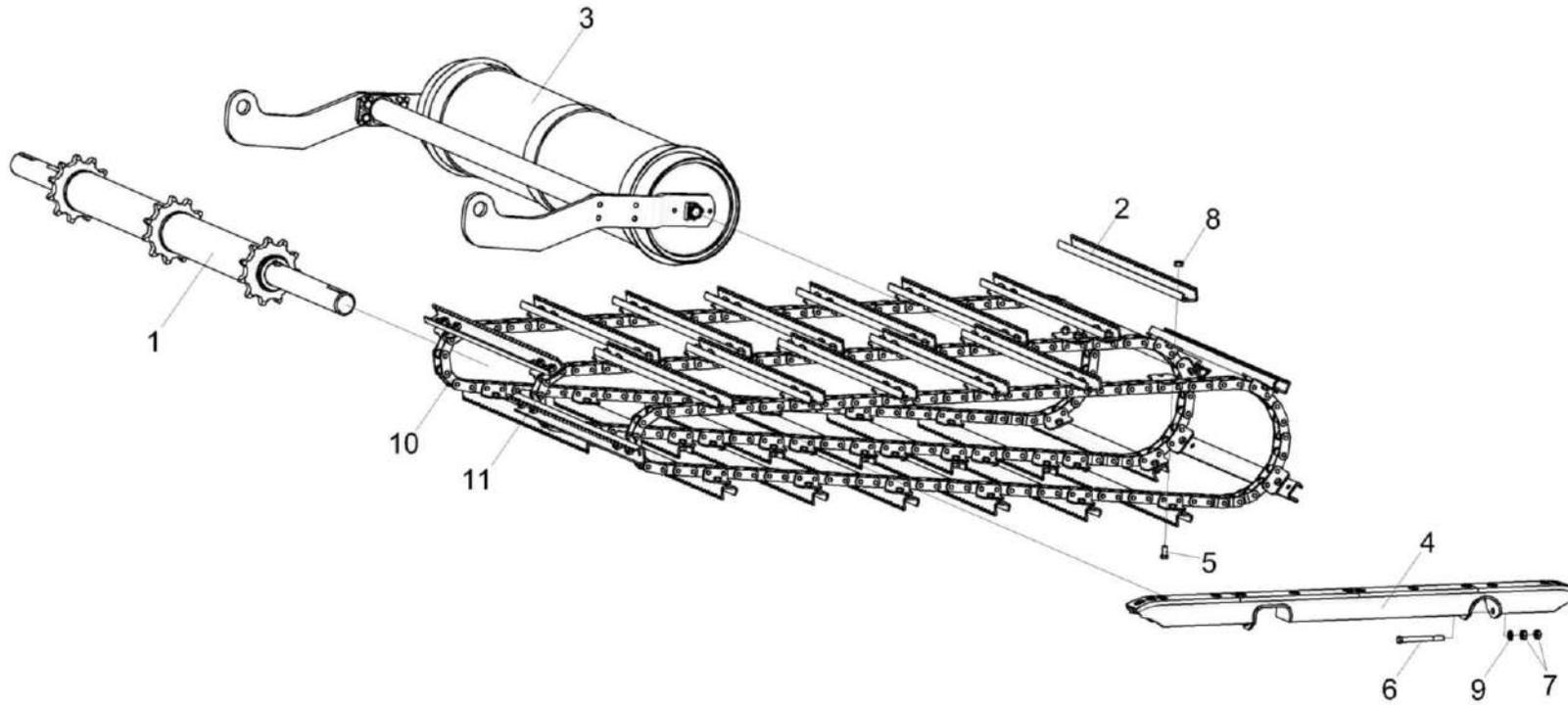
Рисунок 3 – Установка транспортера КЗК-5-1807000А
