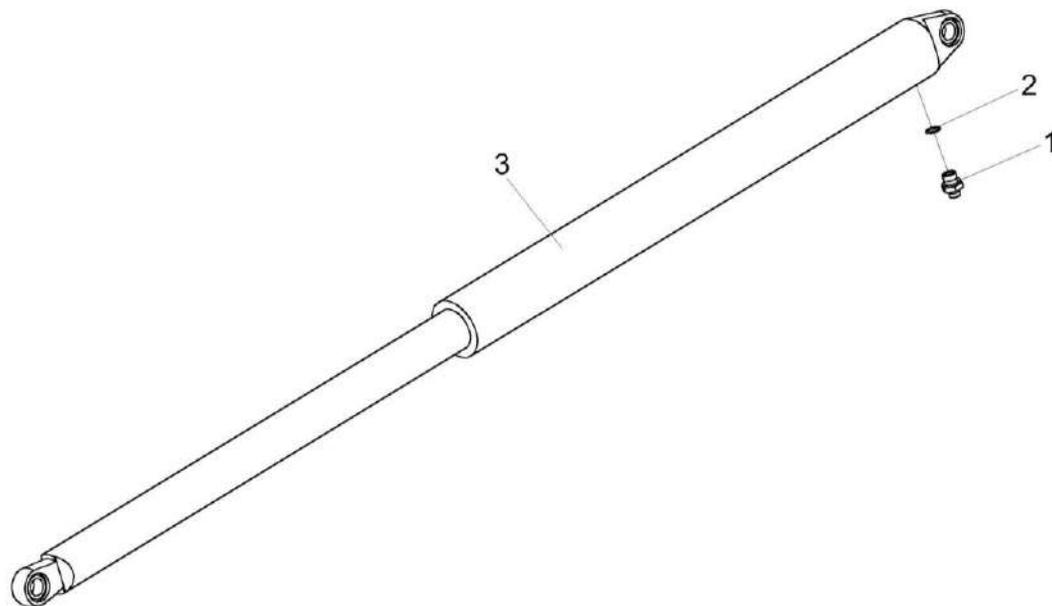
Рисунок 286 – Гидроцилиндр КЗК-8-8-0602510
