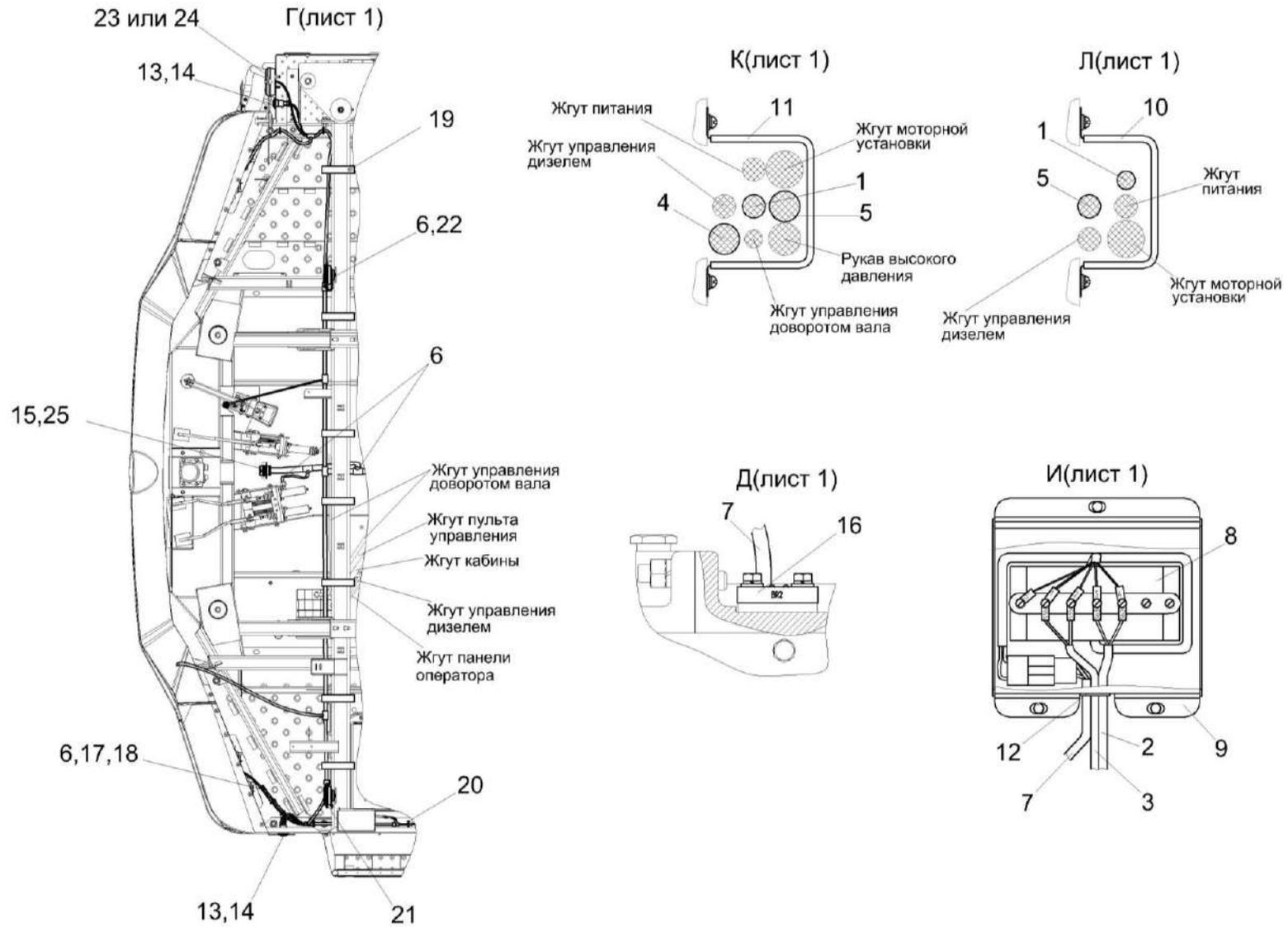
Рисунок 251 – Установка электрооборудования комбайна КЗК-400-1-0721000 (лист 3)
