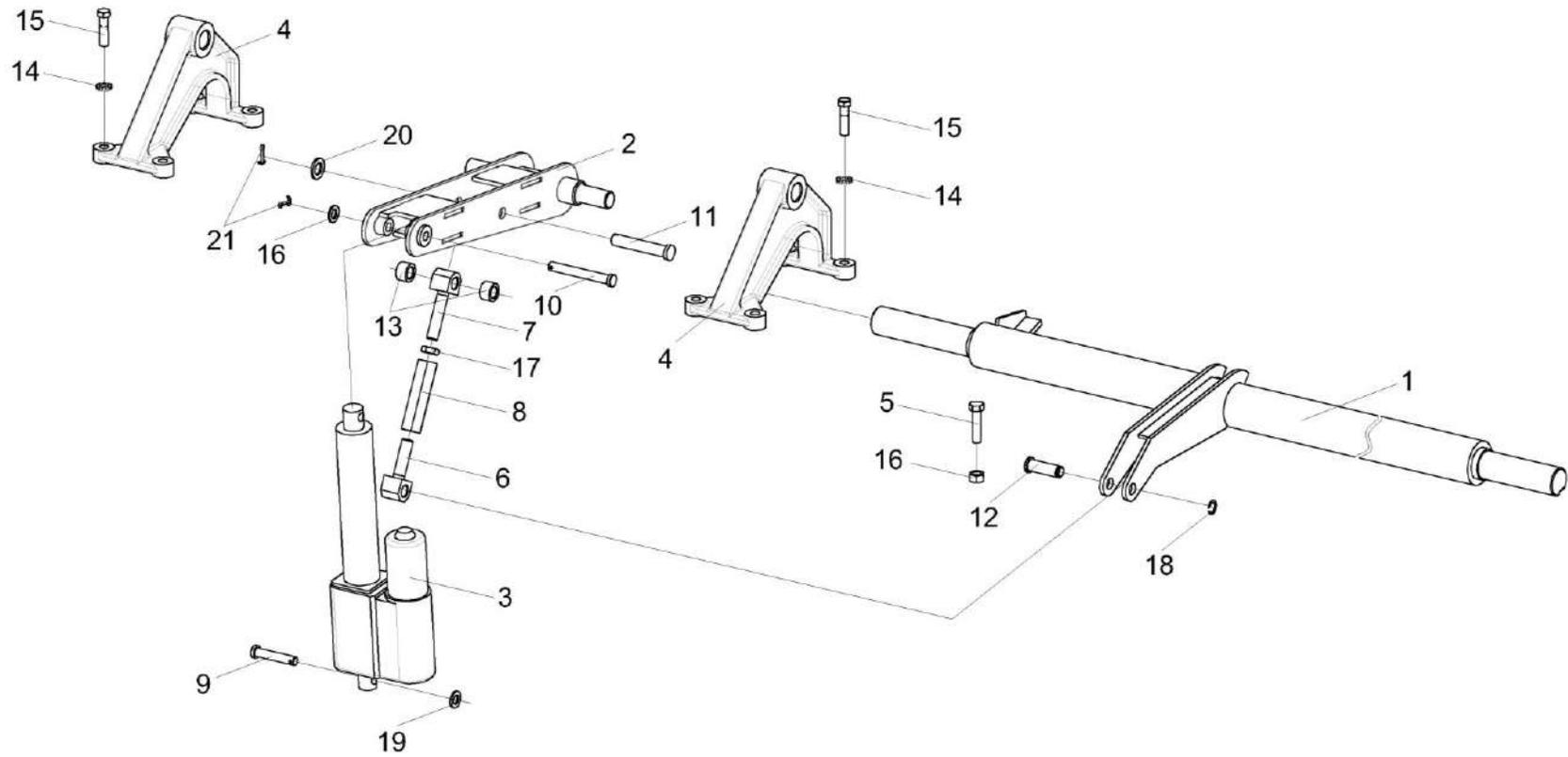
Рисунок 21 – Механизм подъема подбарabanья КЗК-8-9-0115000 (установка электромеханизма)
