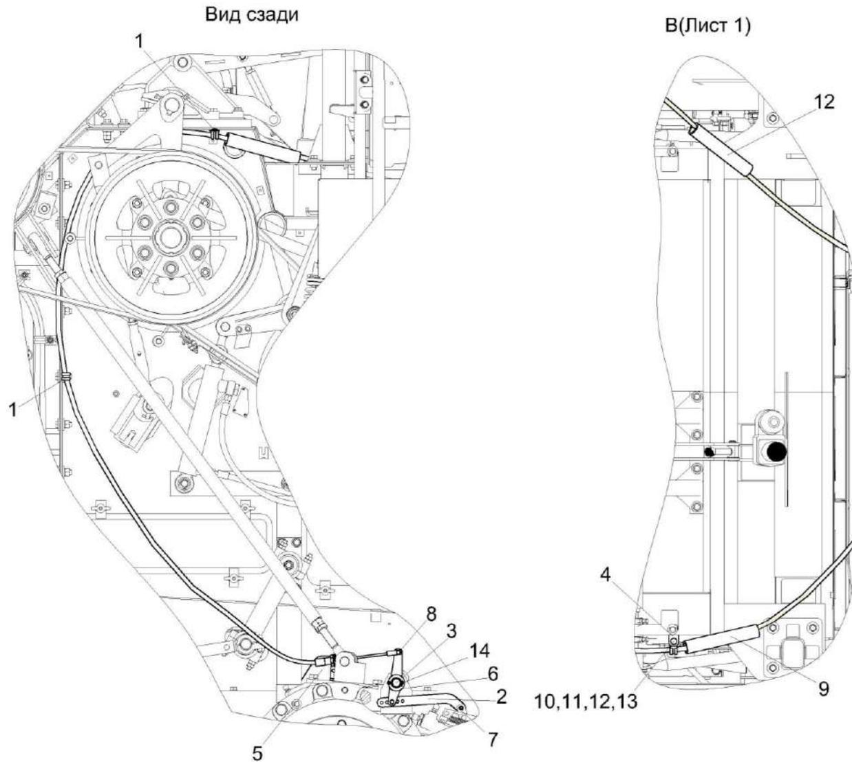
Рисунок 174 – Установка тросов управления стояночным тормозом КЗК-8-9-0119610 (лист 2)
