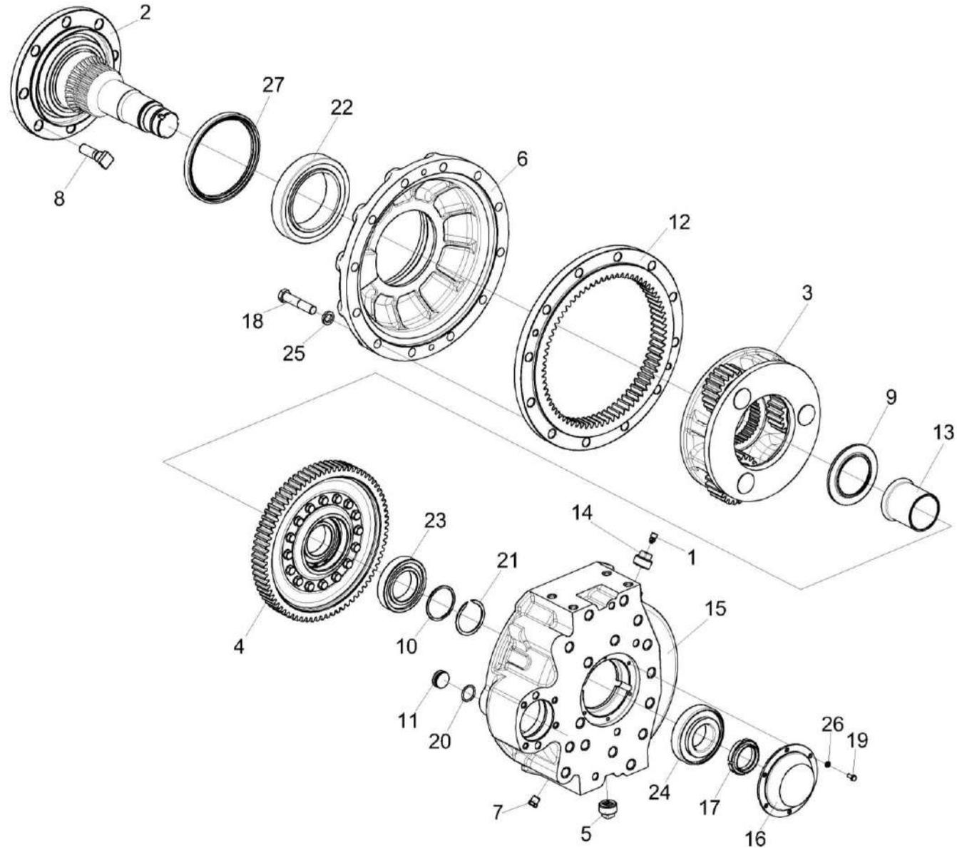
Рисунок 32 – Редуктор бортовой КЗК-400-1-0107020 и КЗК-400-1-0107020-01 (лист 1)
