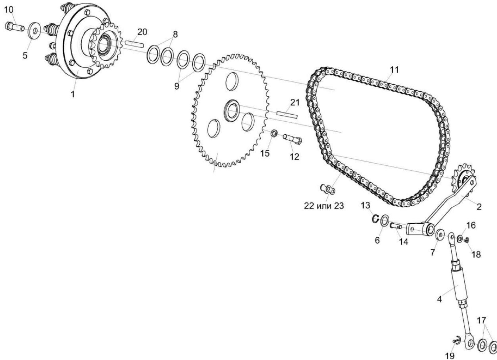
Рисунок 114 – Установка привода половонабивателя КЗК-400-1-0400020
