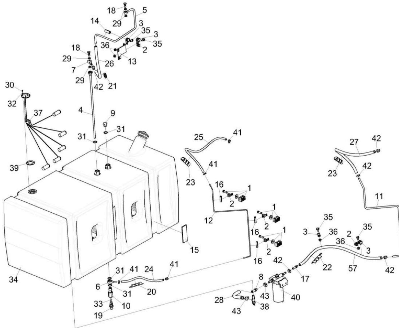
Рисунок 179 - Установка топливного оборудования КЗК-400-1-0126000 (лист 1)
