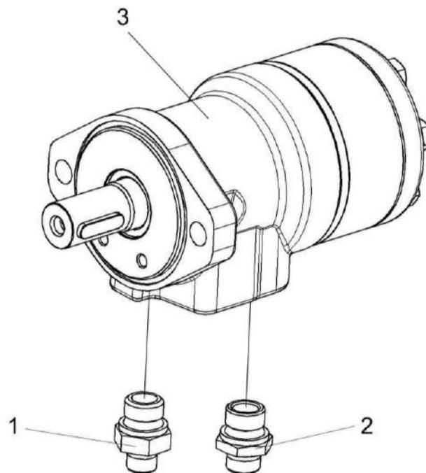
Рисунок 12 – Гидромотор КЗК-12-1790990Б
