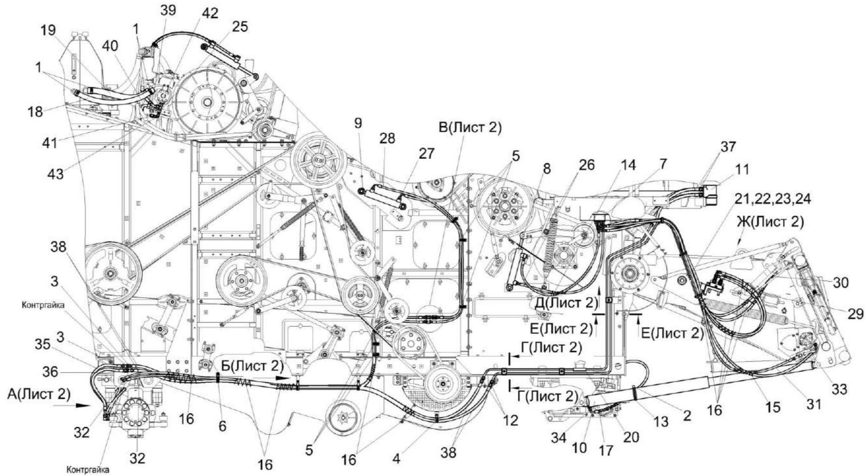
Рисунок 272 – Гидросистема рулевого управления и силовых гидроцилиндров КЗК-400-1-0602000 (лист 1)
