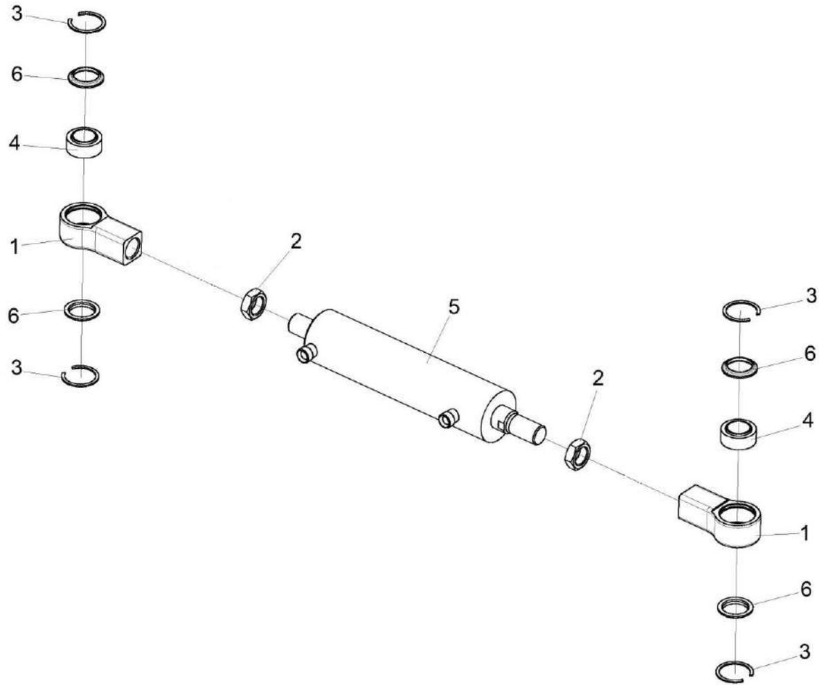
Рисунок 46 – Гидроцилиндр УЭС-7-0109200
