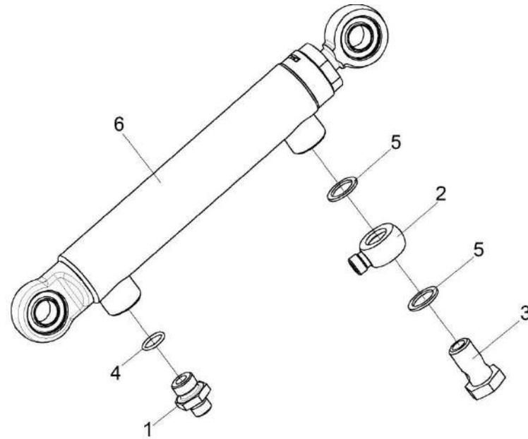
Рисунок 284 – Гидроцилиндр КЗК-8-8-0602500
