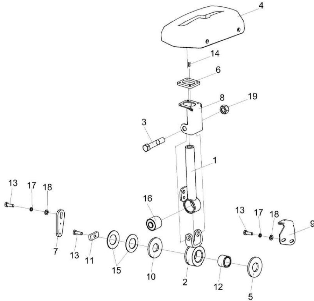
Рисунок 157 – Установка привода ГСТ УКЗ-01-0205110
