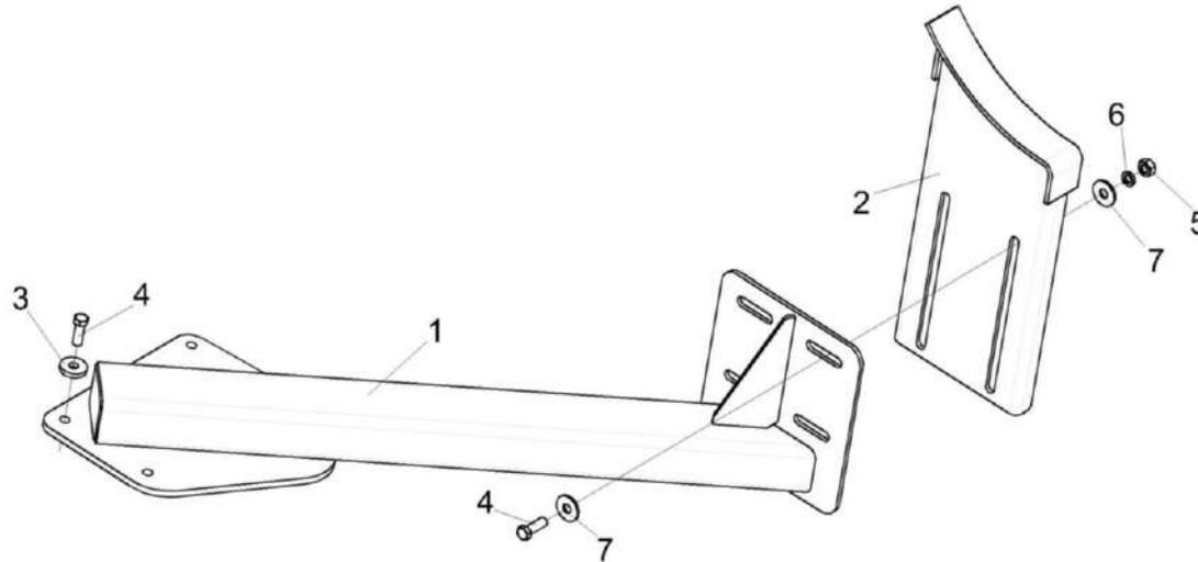
Рисунок 225 – Установка опоры КЗК-400-1-0100590
