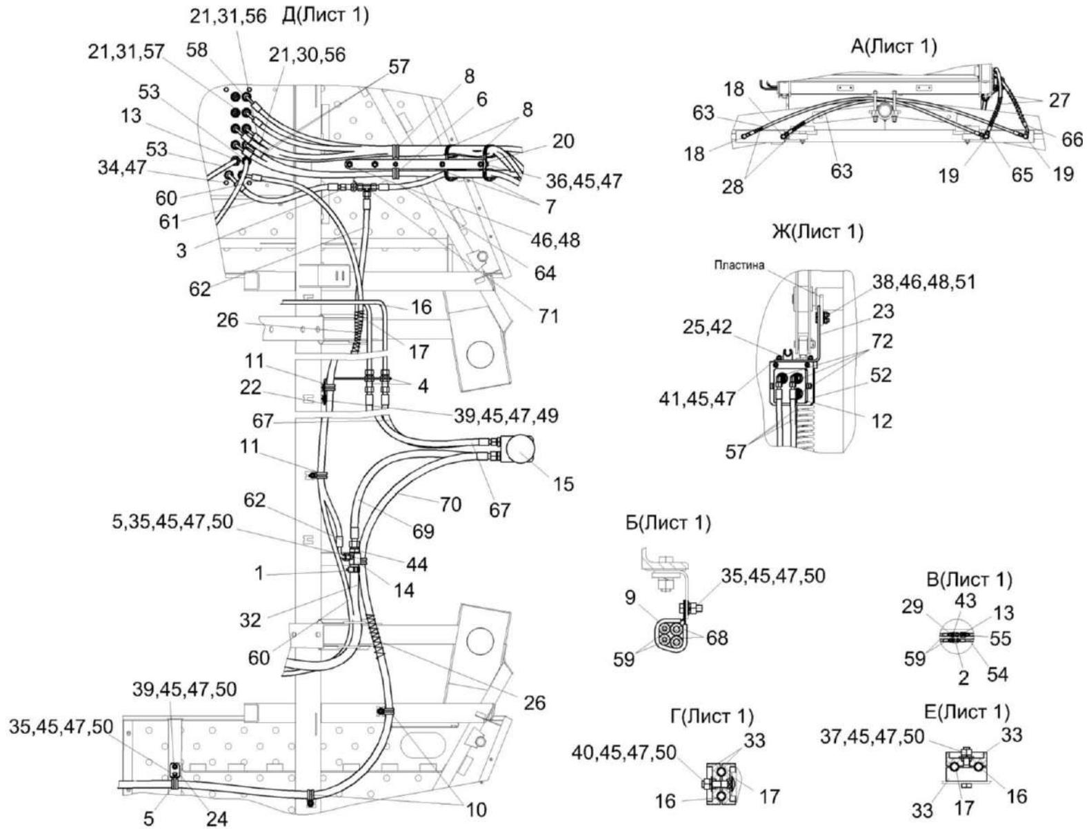
Рисунок 273 – Гидросистема рулевого управления и силовых гидроцилиндров КЗК-400-1-0602000 (лист 2)
