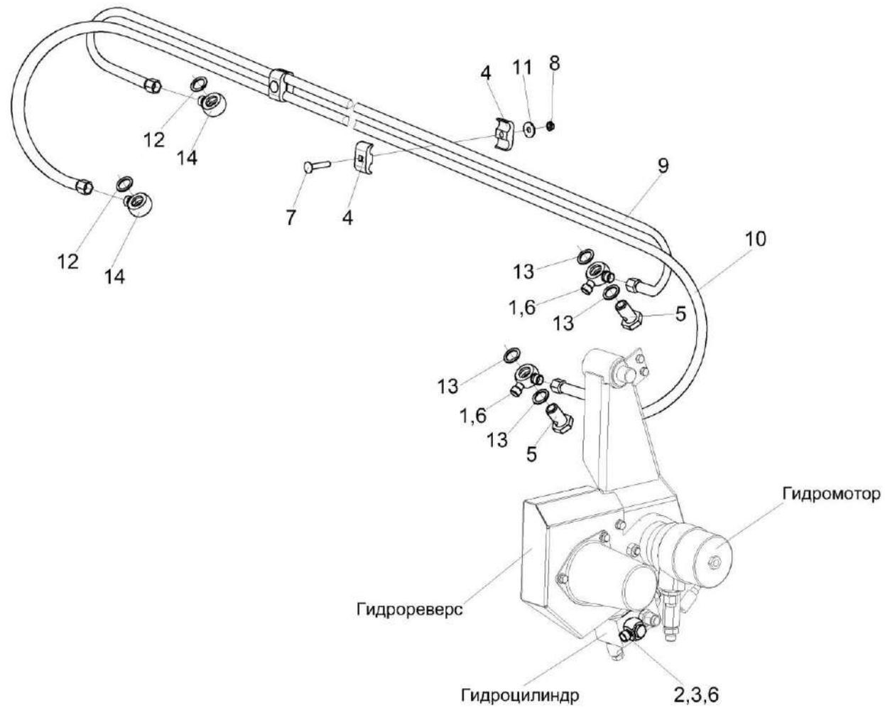
Рисунок 22 – Гидросистема наклонной камеры КЗК-8-8-1790000
