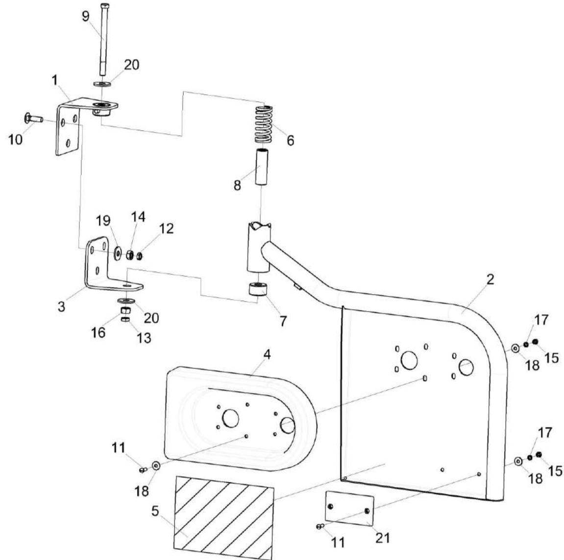
Рисунок 219 – Установка кронштейна КЗК-400-1-0100170 и КЗК-400-1-0100170-01
