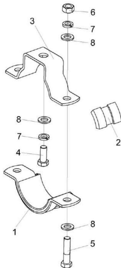
Рисунок 170 – Установка ресивера КЗК-8-3-0113050
