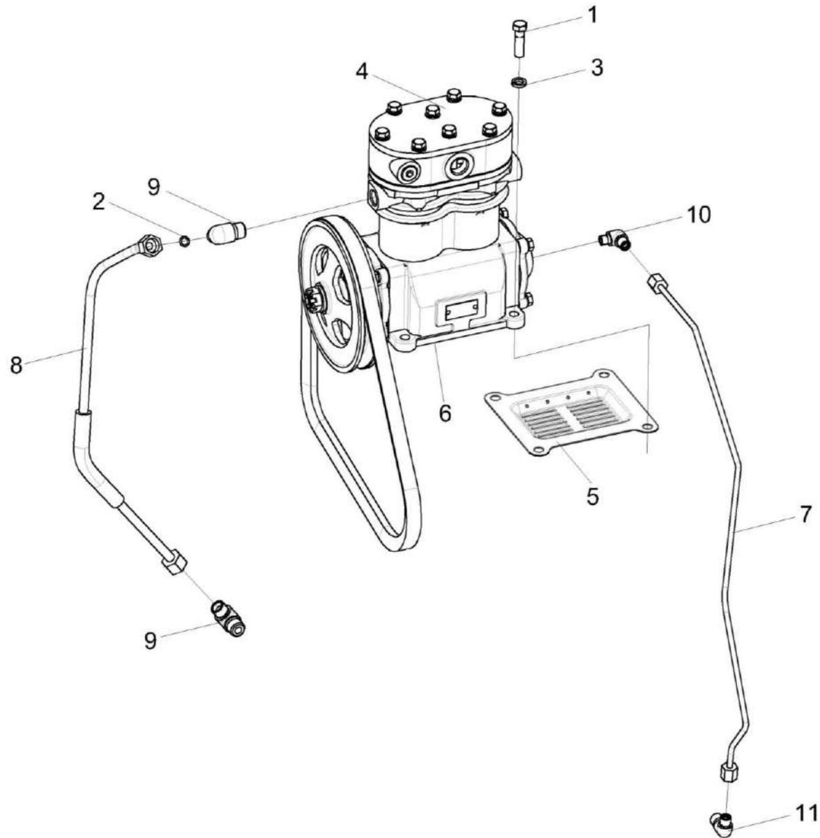
Рисунок 197 – Установка компрессора КЗК-12-3-0106800
