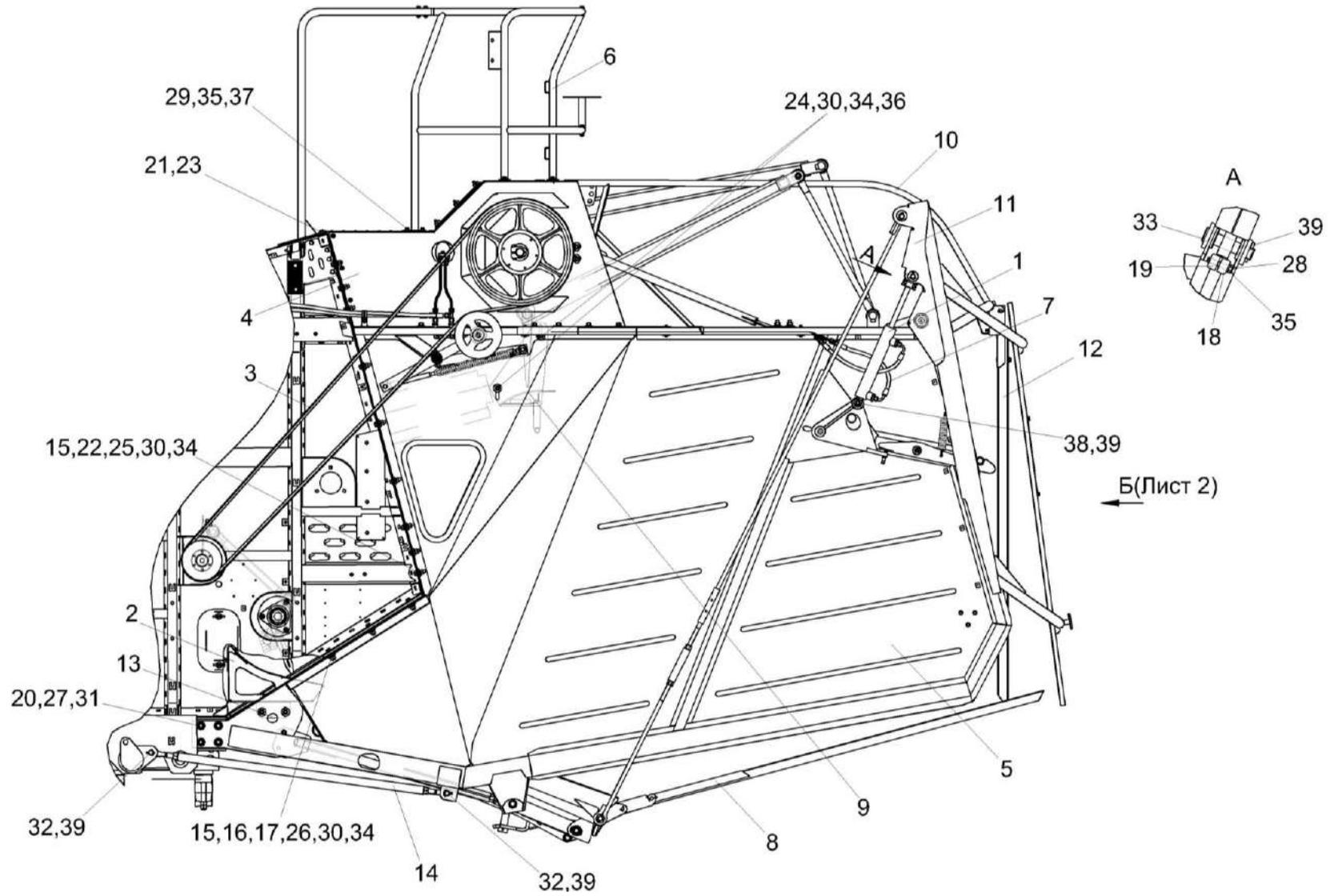
Рисунок 111 – Установка копнителя КЗК-400-1-0400000 (лист 1)
