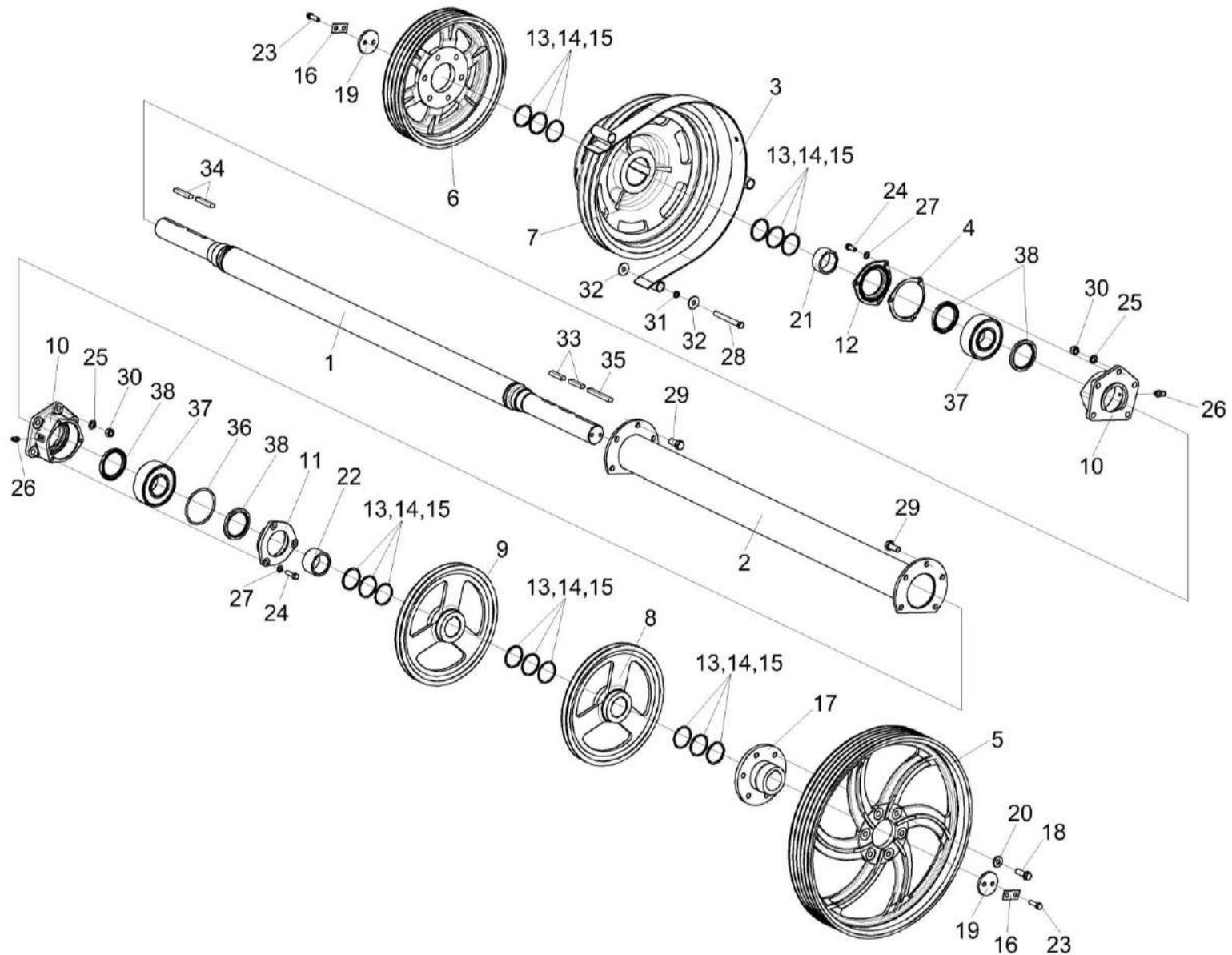
Рисунок 61 – Установка шкивов КЗК 0202860А и КЗК 0202103Б
