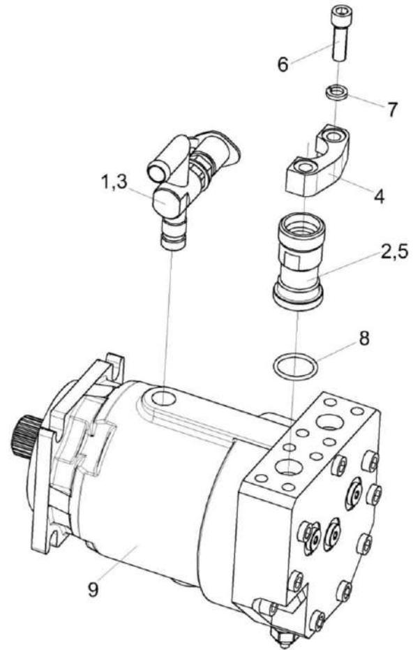
Рисунок 270 – Гидромотор КЗК-8-9-0601200
