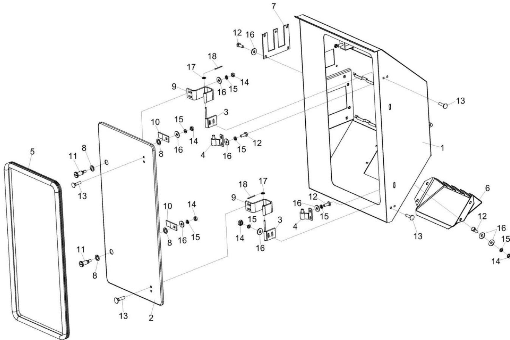
Рисунок 172 – Шкаф электрический КЗК-7-0116000
