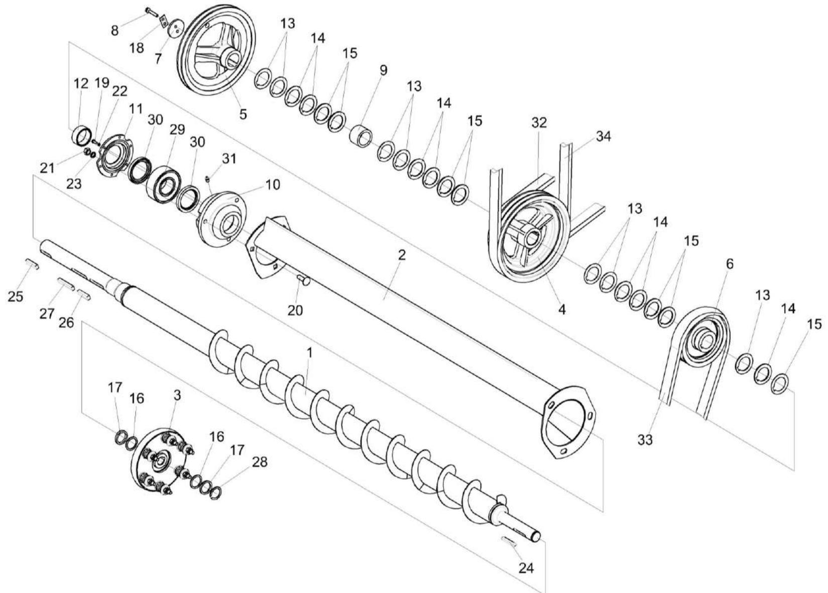
Рисунок 62 – Установка шкивов на шнек распределительный КЗК-8-9-0202770
