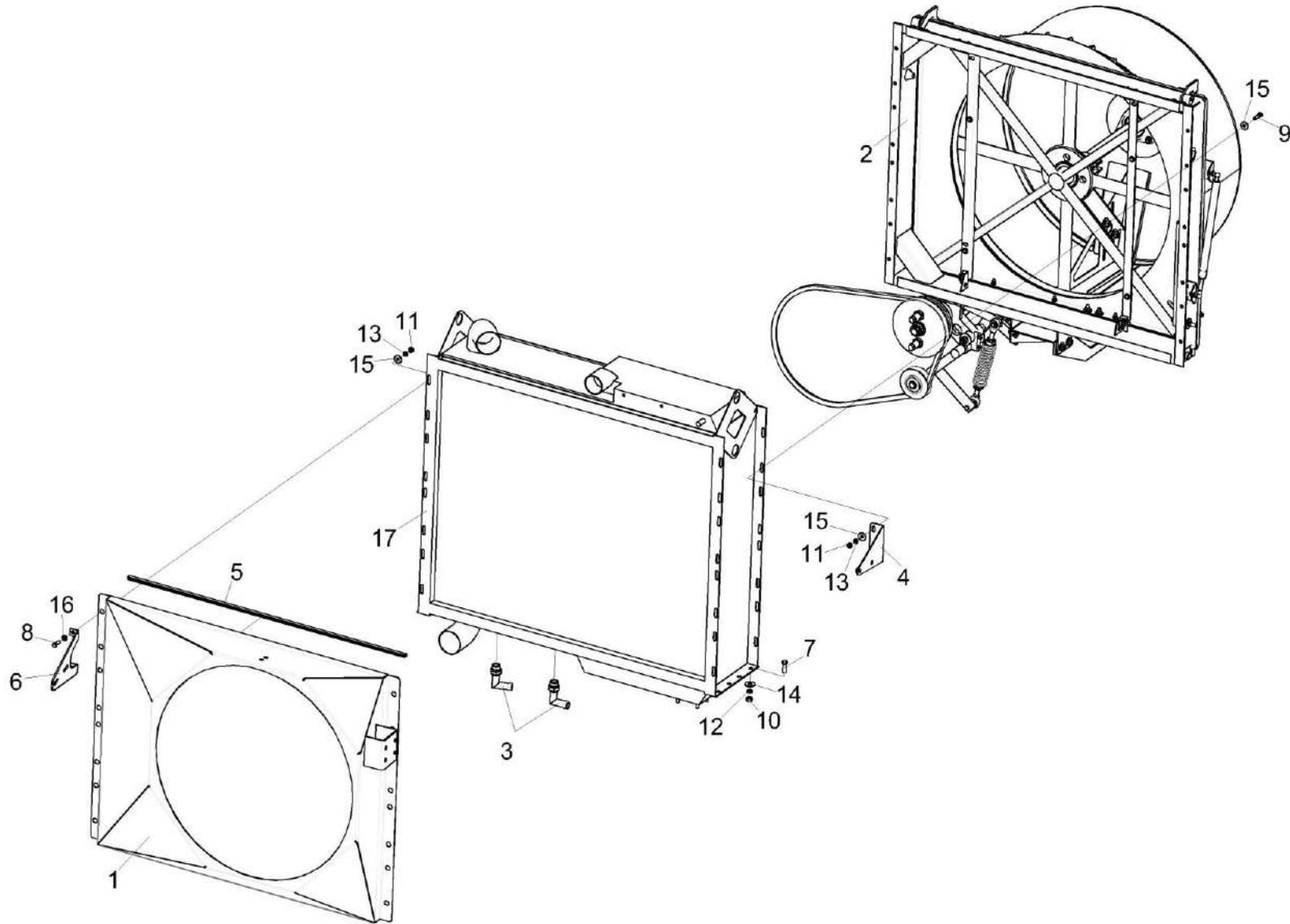
Рисунок 188 – Блок радиаторов КЗК-8-9-0106040
