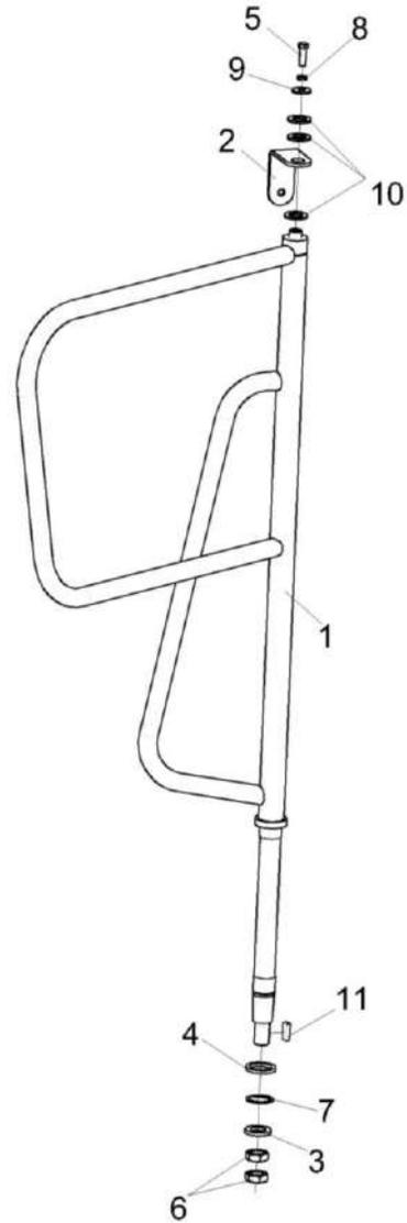
Рисунок 237 – Установка поручня КЗК-8-9-0121060
