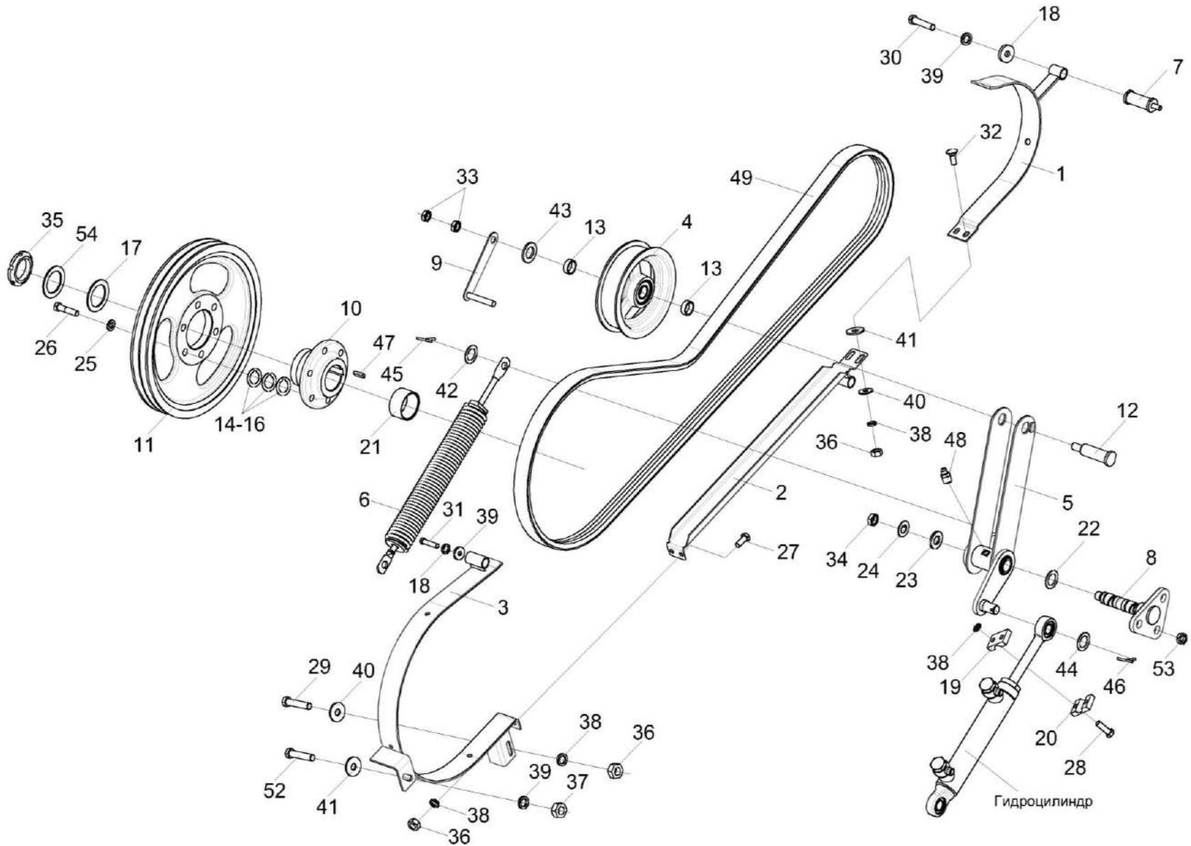
Рисунок 244 – Привод горизонтального шнека КЗК-10-0221000
