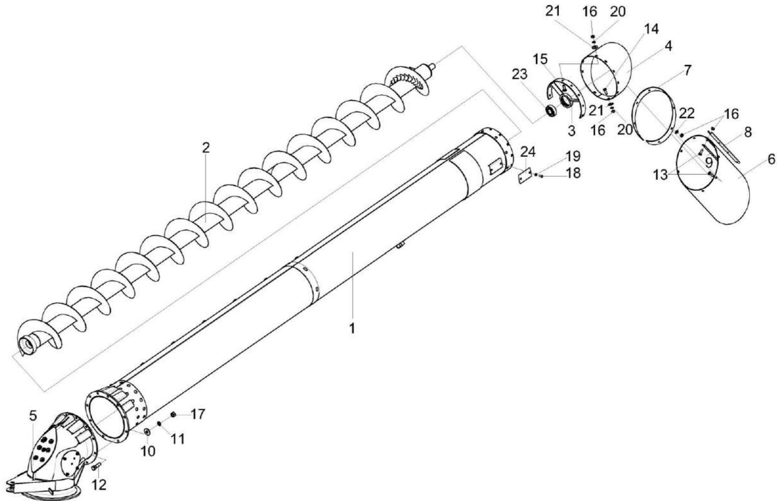
Рисунок 106 – Шнек с отводом КЗК-3219-0206000А-01
