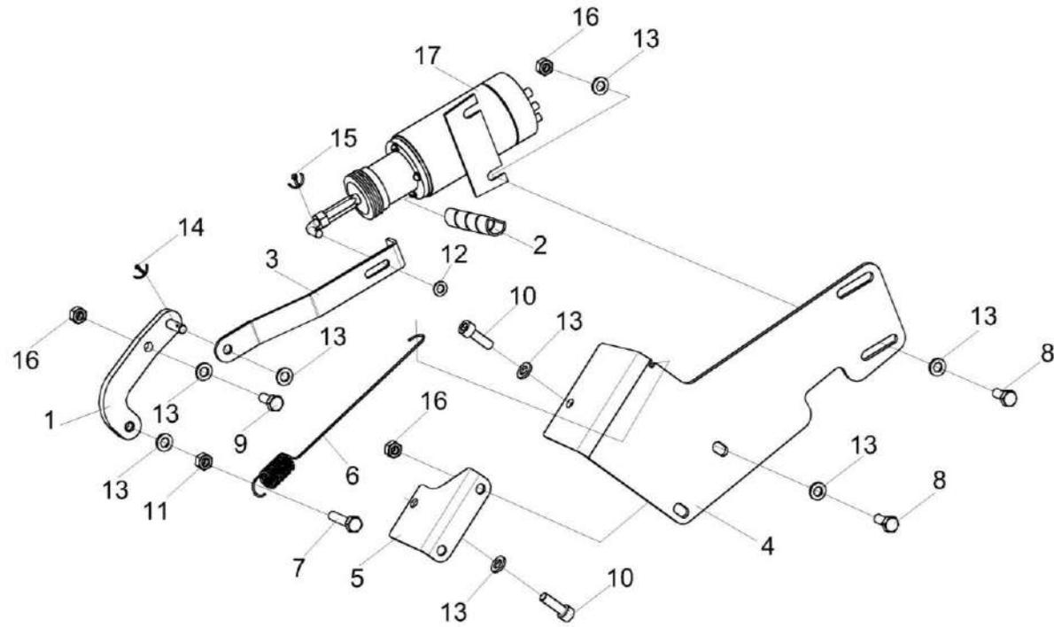
Рисунок 223 – Установка привода КЗК-12-22-0119690А
