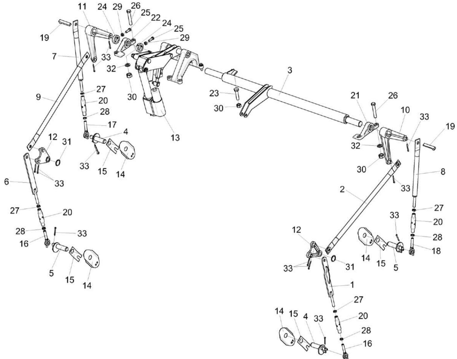
Рисунок 20 – Механизм подъема подбарабанья КЗК-8-9-0115000
