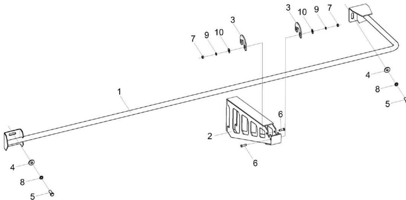
Рисунок 221 - Установка лестничных опор КЗК-8-9-0100500
