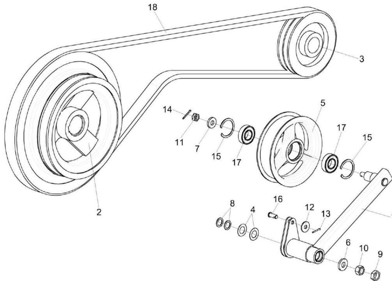
Рисунок 56 – Установка рычага КЗК-12-0202820
