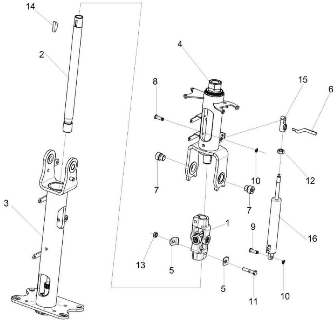
Рисунок 148 – Каркас КЗК-13-0119240
