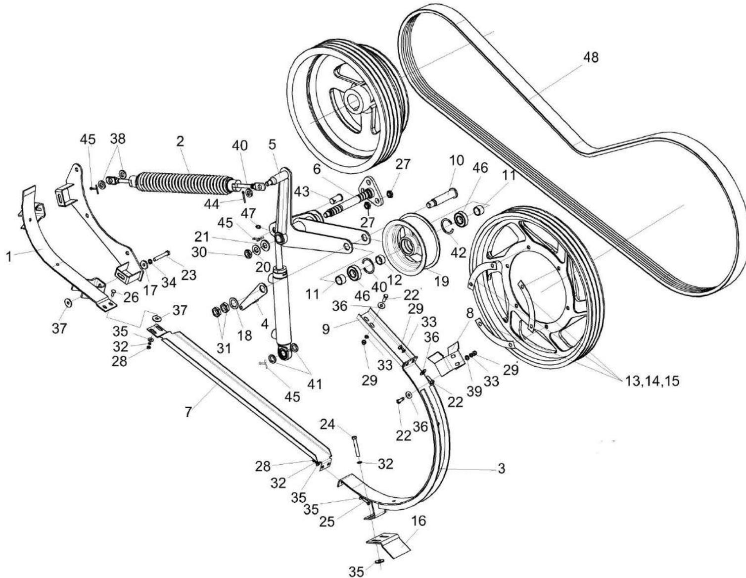
Рисунок 295 – Привод наклонной камеры КЗК 0125000
