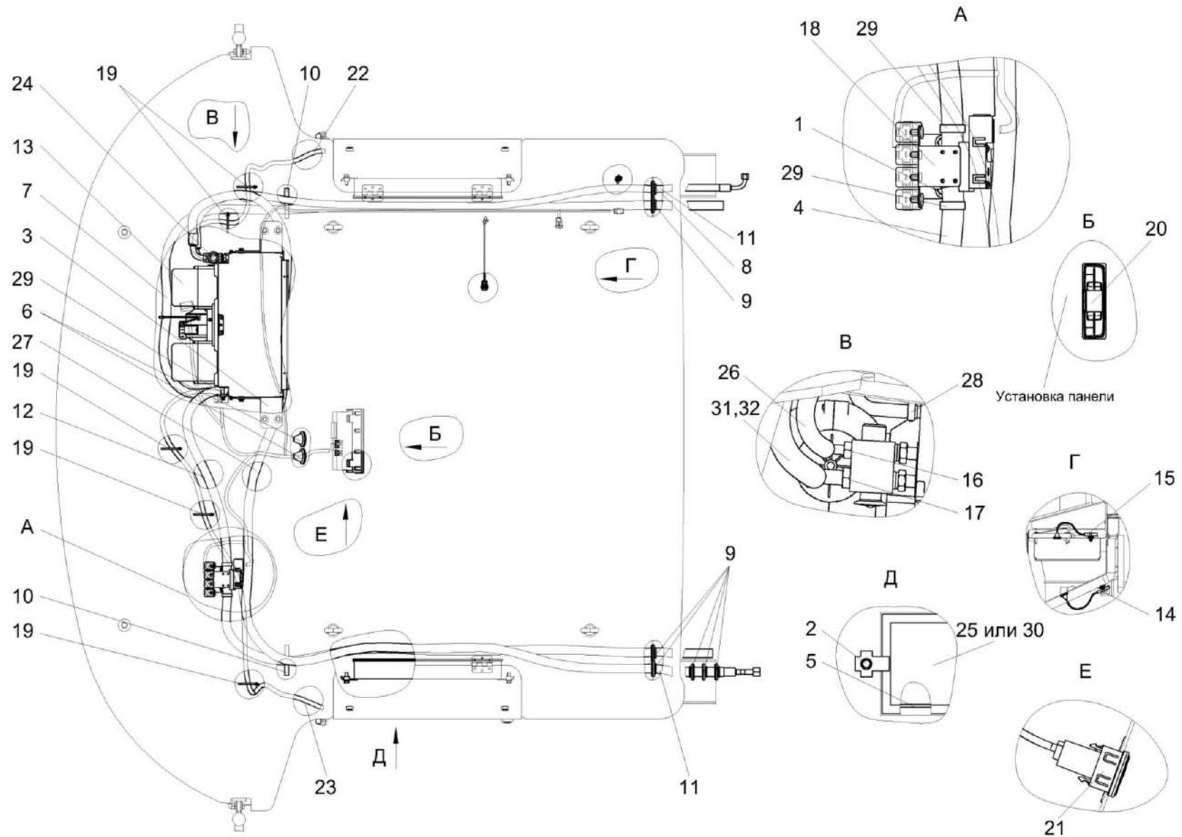
Рисунок 167 – Установка испарителя КЗК-8-9-0113020
