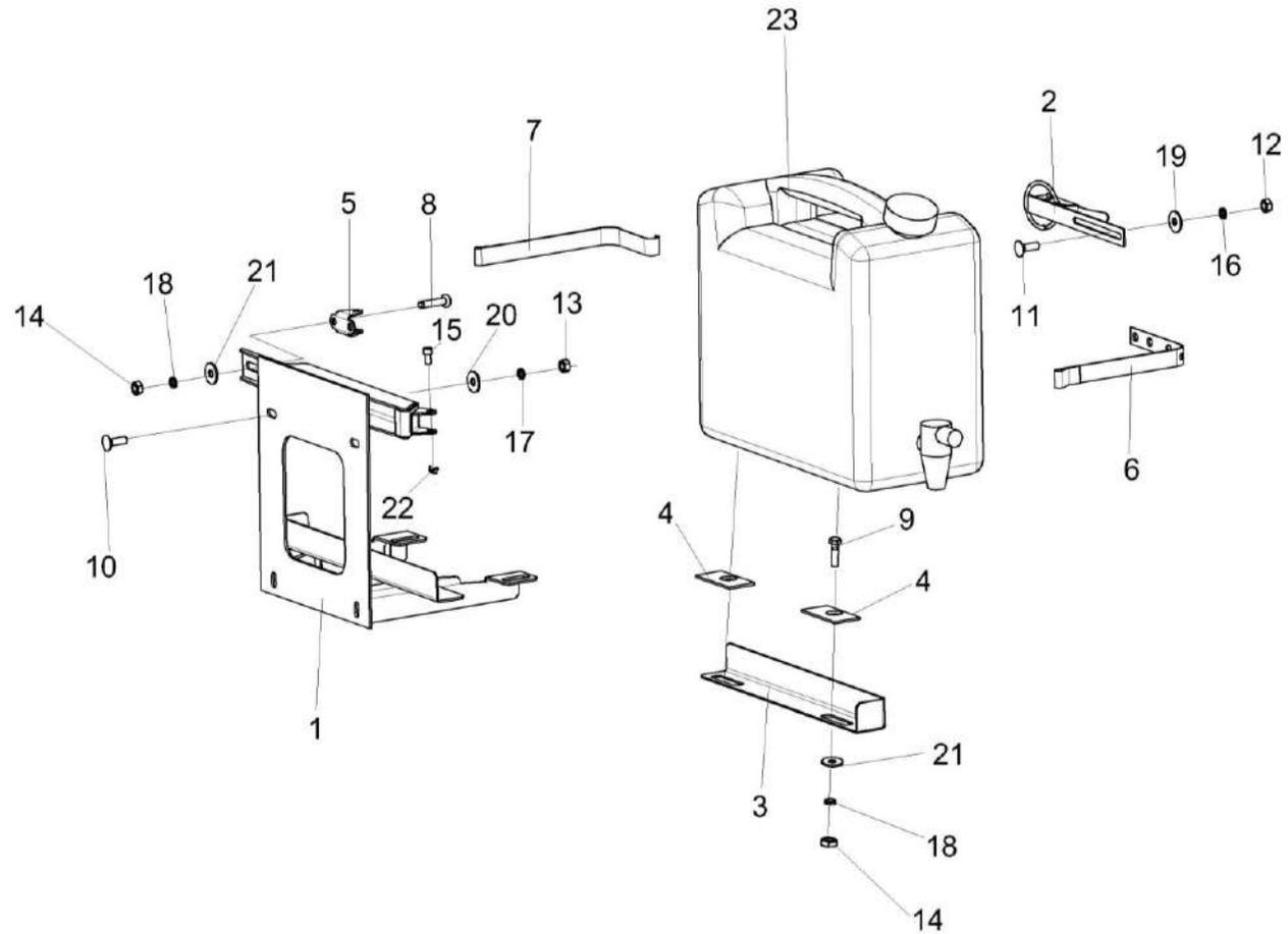
Рисунок 247 – Установка бачка КЗК-8М-0100100
