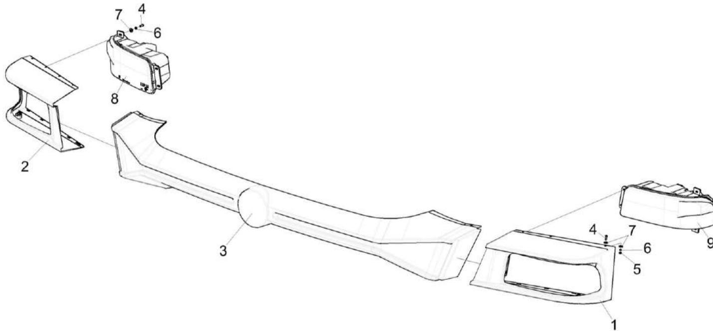
Рисунок 242 – Установка бампера и масок КЗК-8-9-0132000
