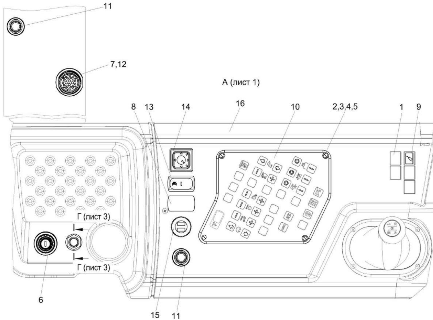
Рисунок 257 – Установка электрооборудования пульта управления КЗК-400-1-0725000 (лист 2)
