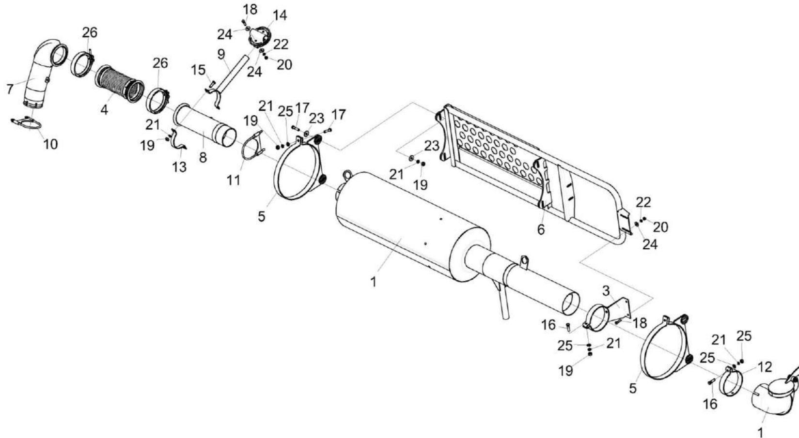
Рисунок 200 – Установка глушителя КЗК-8-9-0106060
