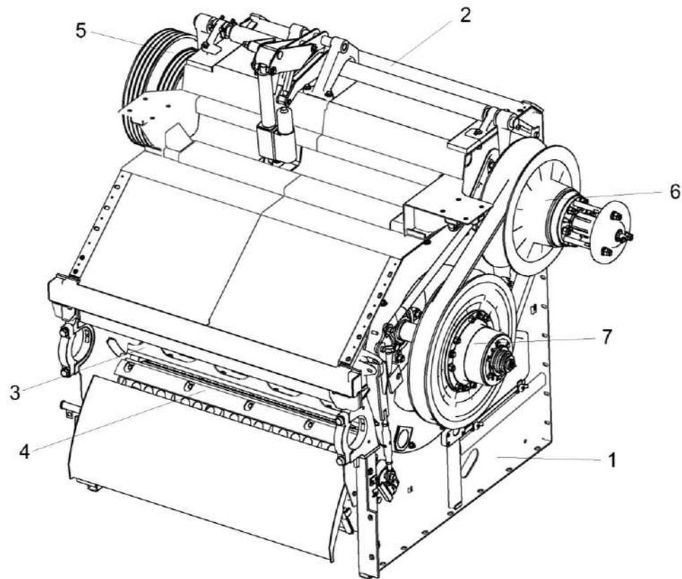
Рисунок 10 - Аппарат молотильный КЗК-8-9-1-0102000
