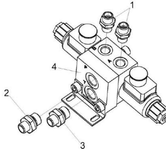
Рисунок 267 – Гидроблок доворота вала мотора ГСТ УЭС-16-0601060-02
