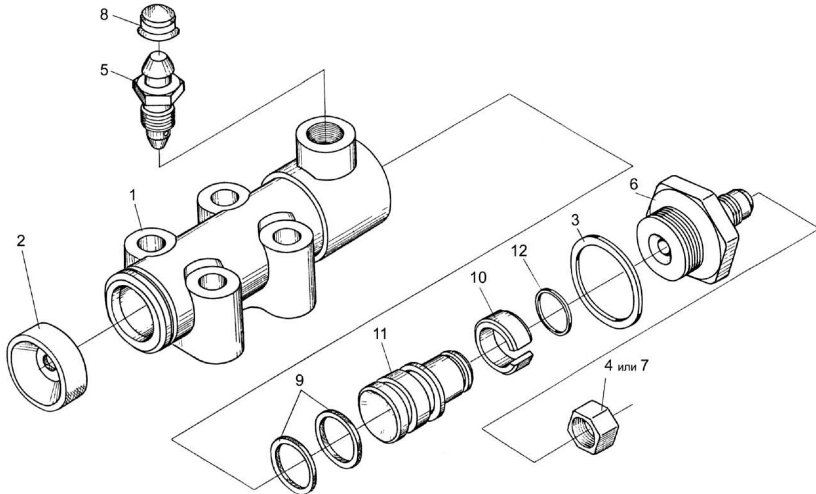
Рисунок 37 – Гидроцилиндр тормоза МК-23М.03.220А
