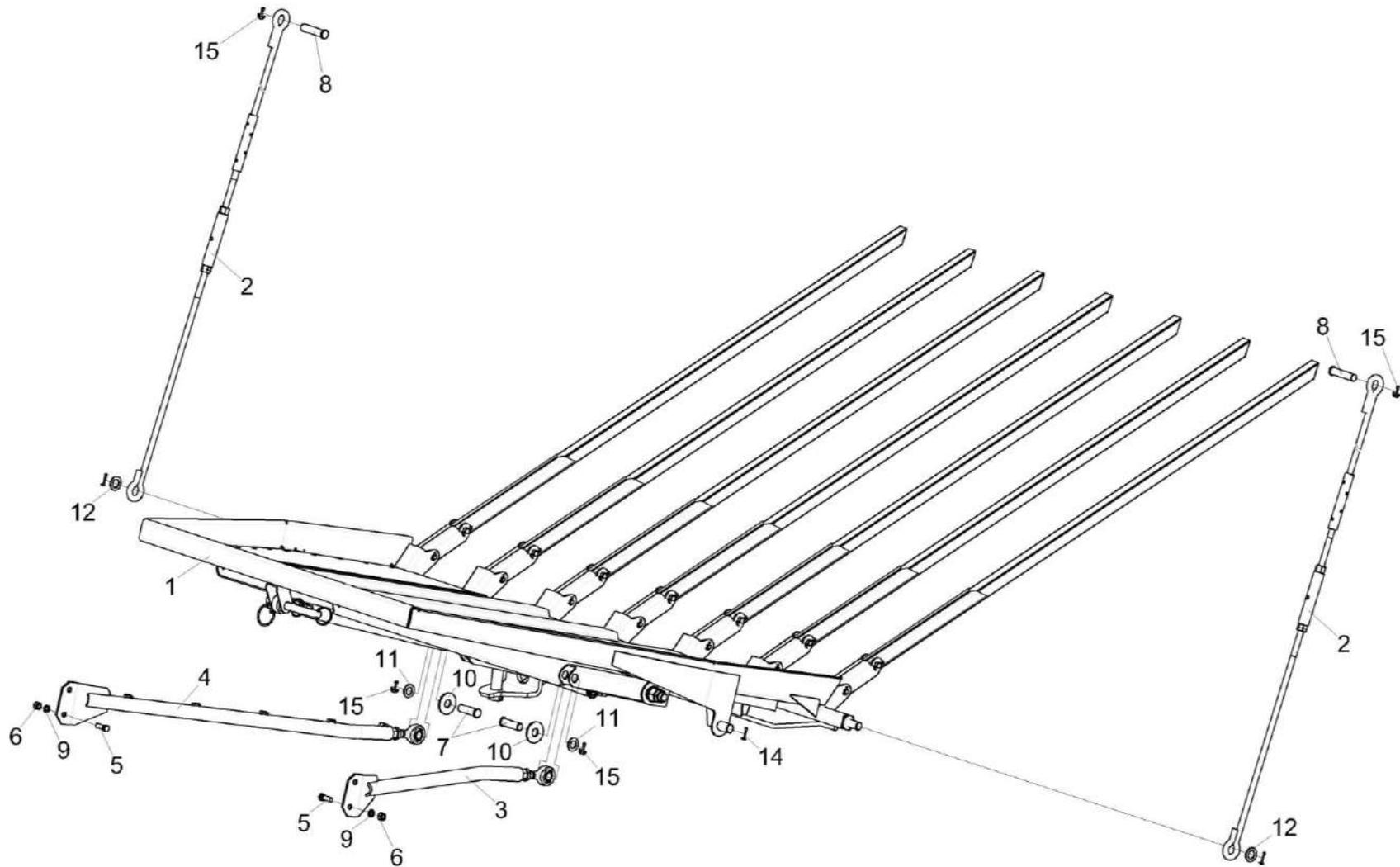
Рисунок 128 – Установка днища копнителя КЗК-8К-0400040
