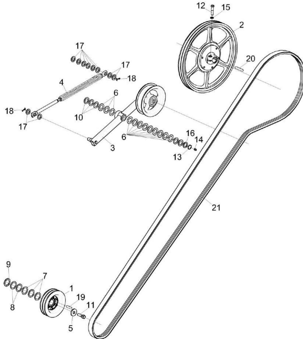
Рисунок 118 – Установка привода солонабивателя КЗК-400-1-0400030
