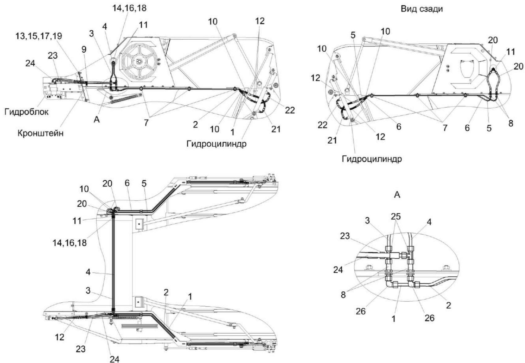
Рисунок 127 – Установка гидросистемы копнителя КЗК-400-1-0602090
