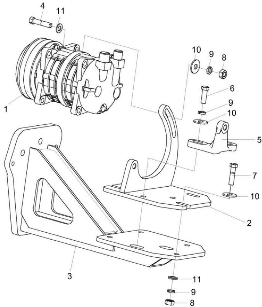
Рисунок 169 – Установка компрессора КЗК-12-0113300
