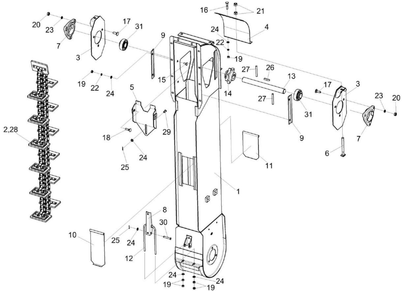
Рисунок 65 – Элеватор колосовой КЗК 0208000Б-03
