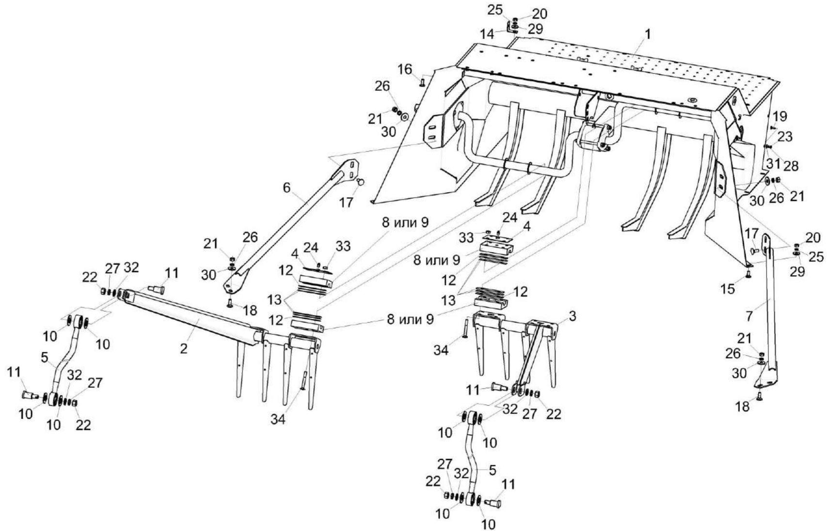
Рисунок 123 – Установка солонабивателя КЗК-400-1-0400050
