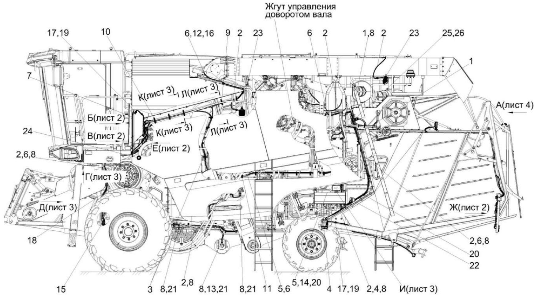
Рисунок 249 – Установка электрооборудования комбайна КЗК-400-1-0721000 (лист 1)
