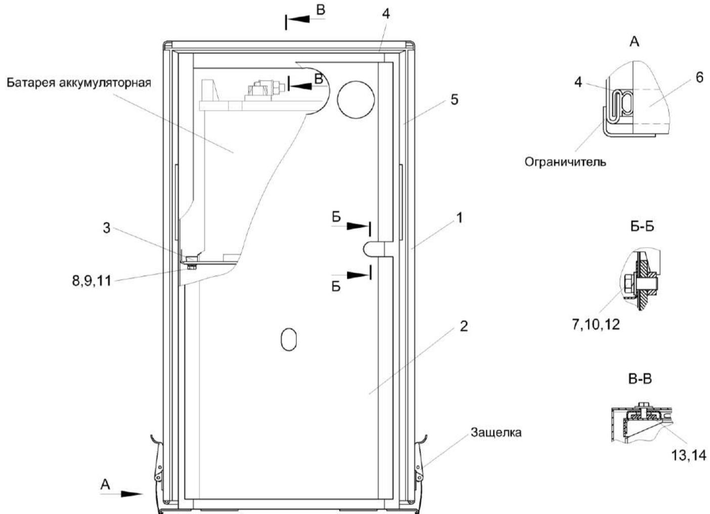
Рисунок 226 – Ящик аккумуляторный КЗК-12-0129000А
