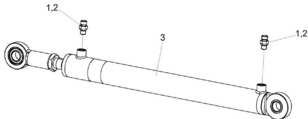
Рисунок 281 – Гидроцилиндр поворота выгрузного шнека КЗК-1420-0602500
