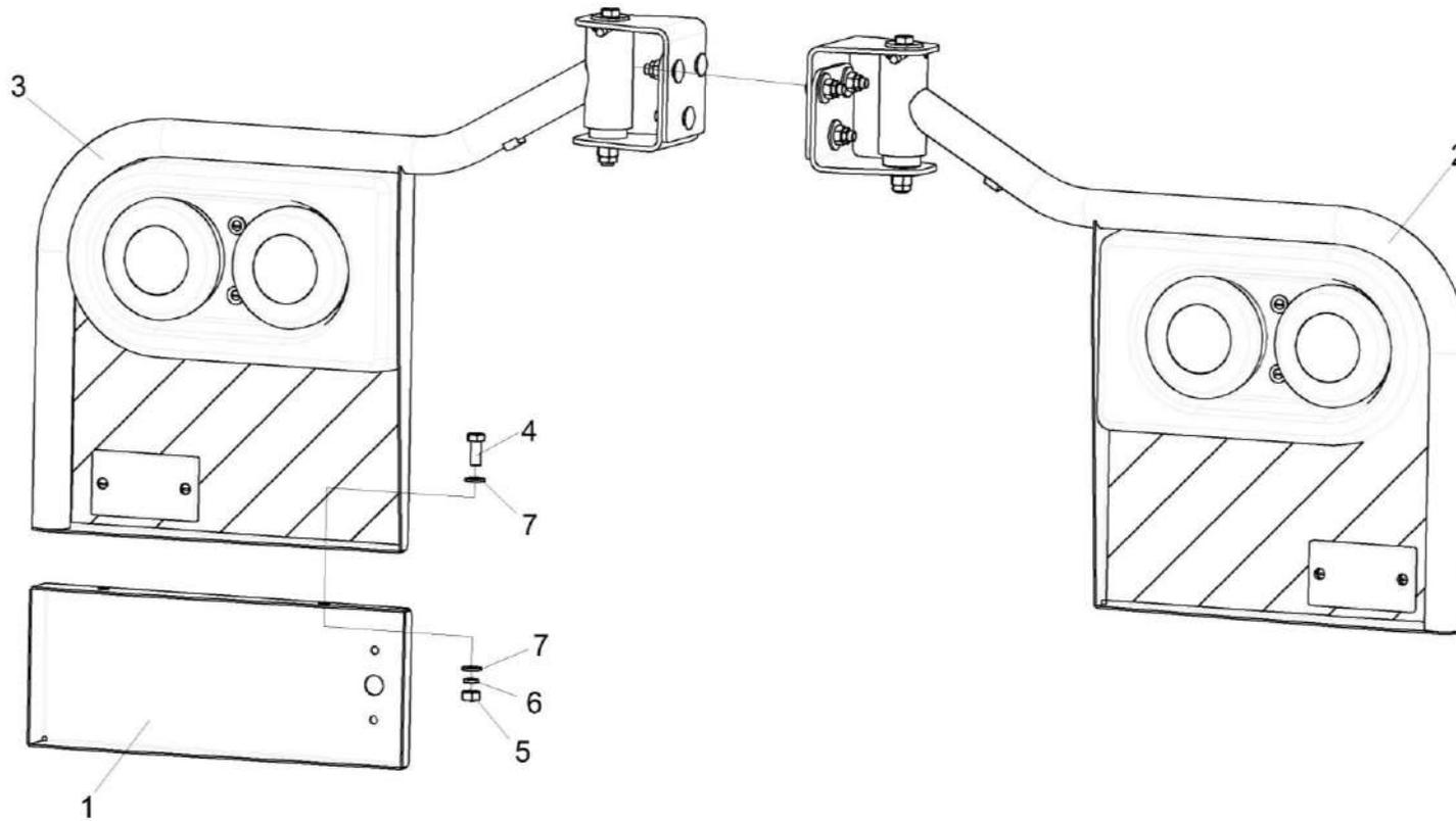
Рисунок 218 – Установка светоотражающих полос КЗК-400-1-0100180
