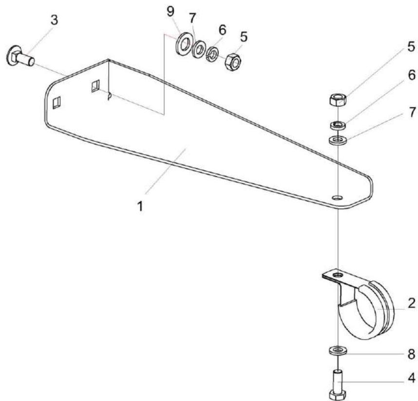
Рисунок 168 – Установка кронштейна КЗК-12-0113190
