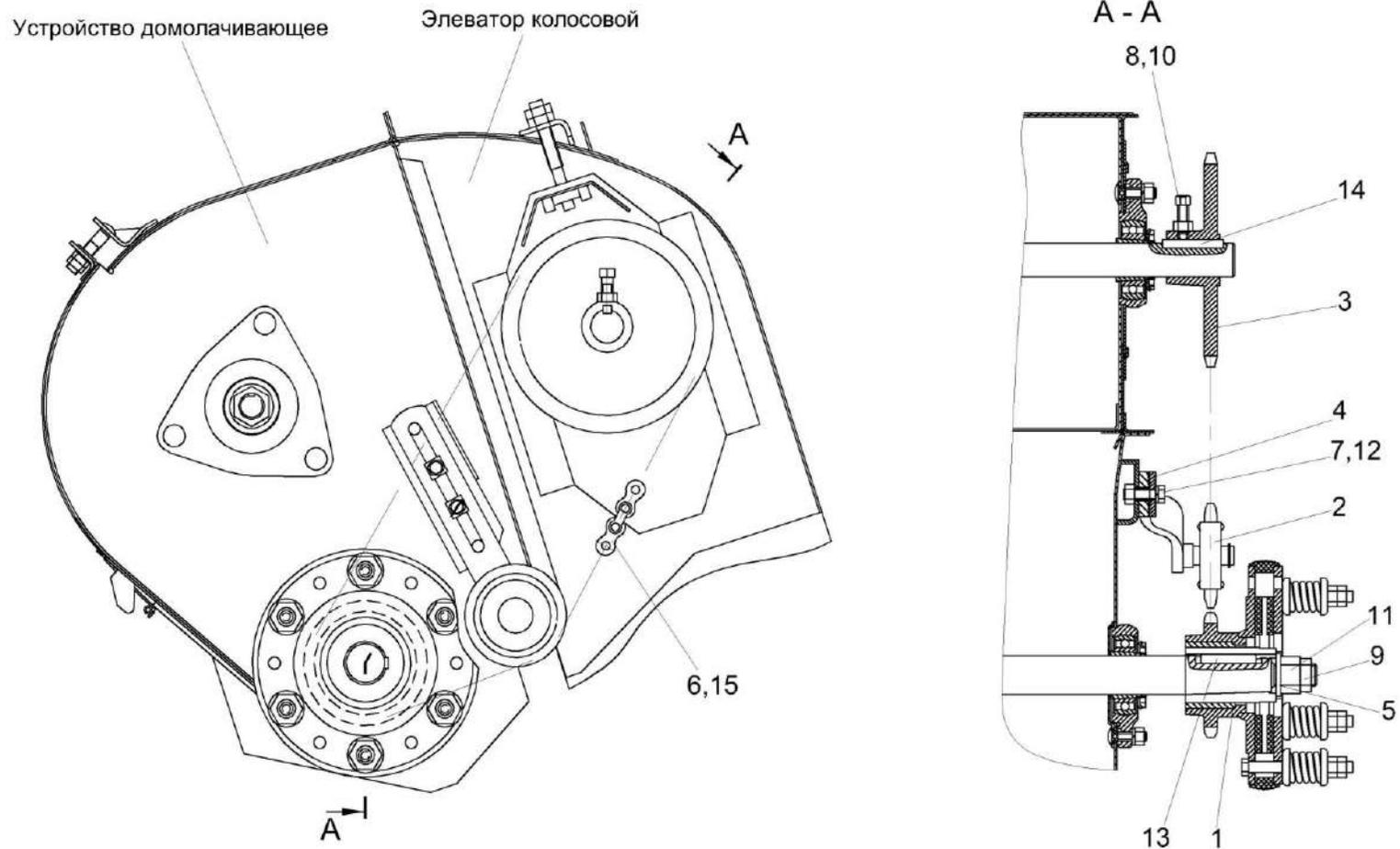
Рисунок 67 – Установка цепного привода элеватора колосового
