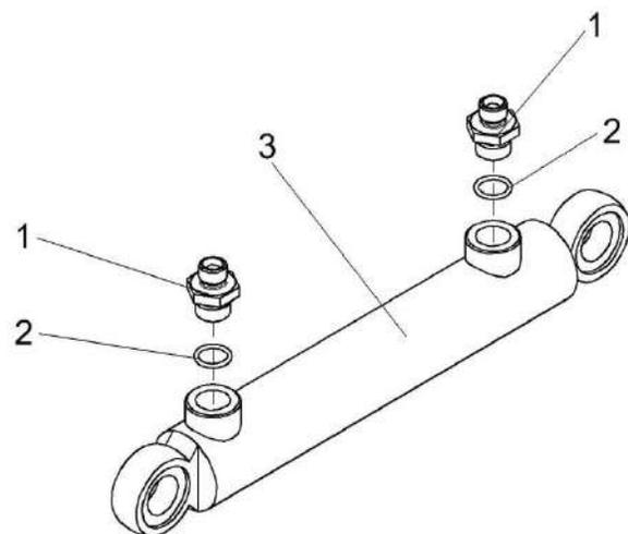
Рисунок 285 – Гидроцилиндр КЗК-8-8-0602500-01
