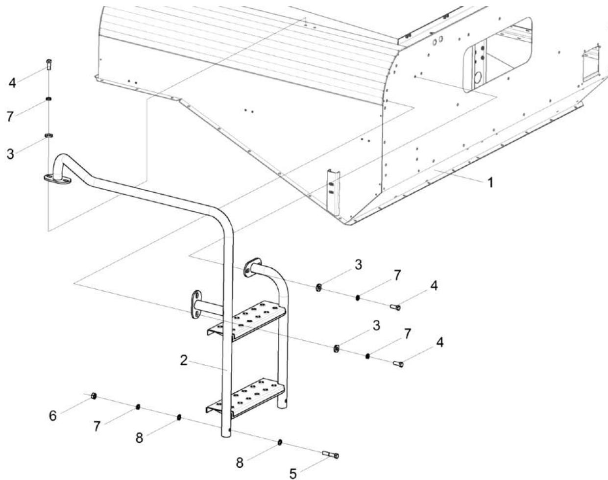
Рисунок 83 - Установка лестницы КЗК-8-9-0203380
