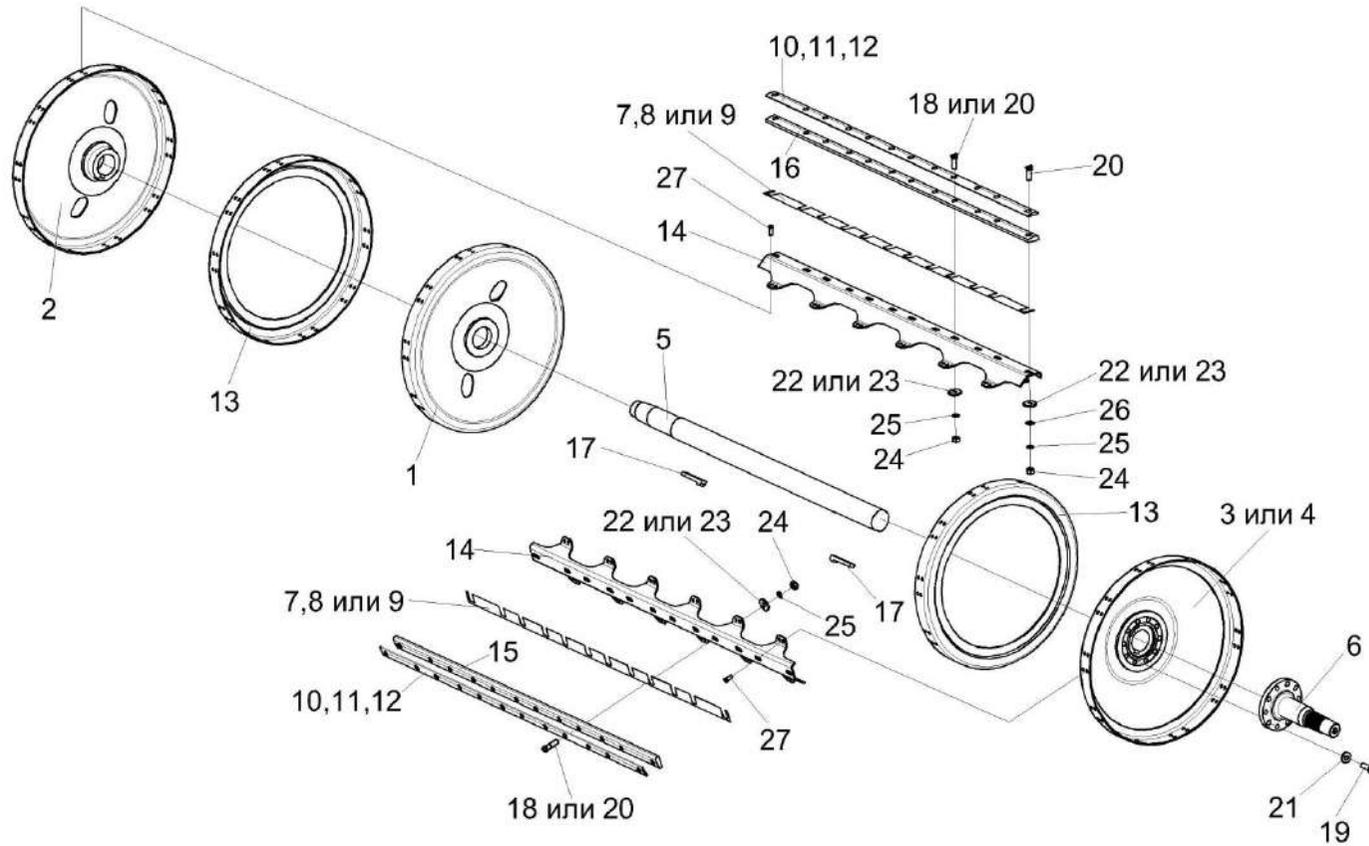
Рисунок 17 – Барабан молотильный КЗК-8А-0104000
