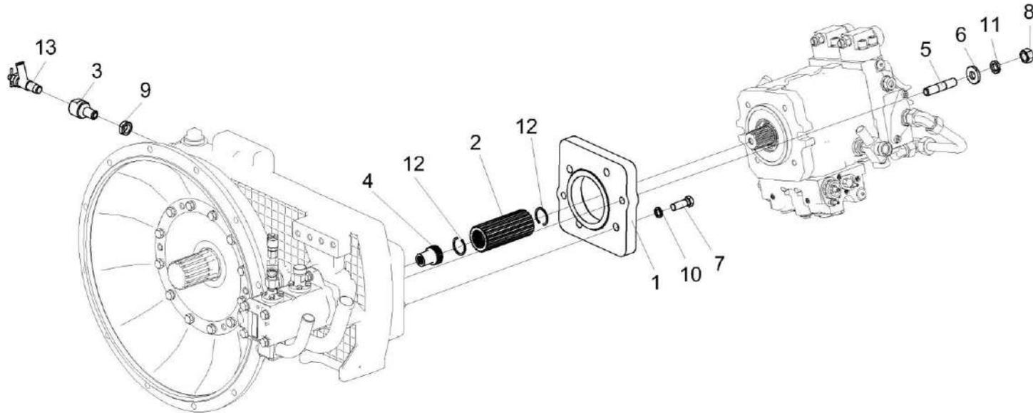
Рисунок 265 – Установка гидронасосов КЗК-8-9-0100200
