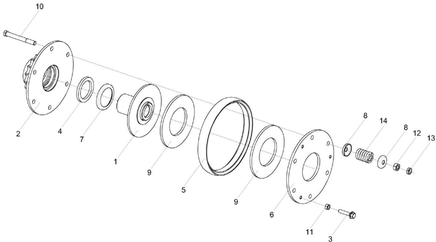
Рисунок 47 - Муфта фрикционная КЗК-8-9-0219020
