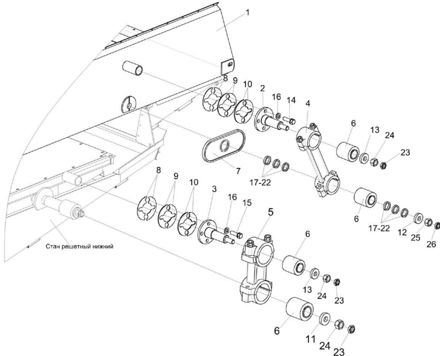
Рисунок 73 – Установка привода стана решетного верхнего КЗК 0260000Б-01
