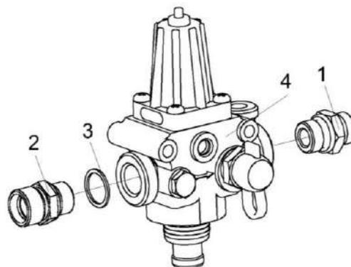
Рисунок 293 – Регулятор давления КЗК-10-0800190
