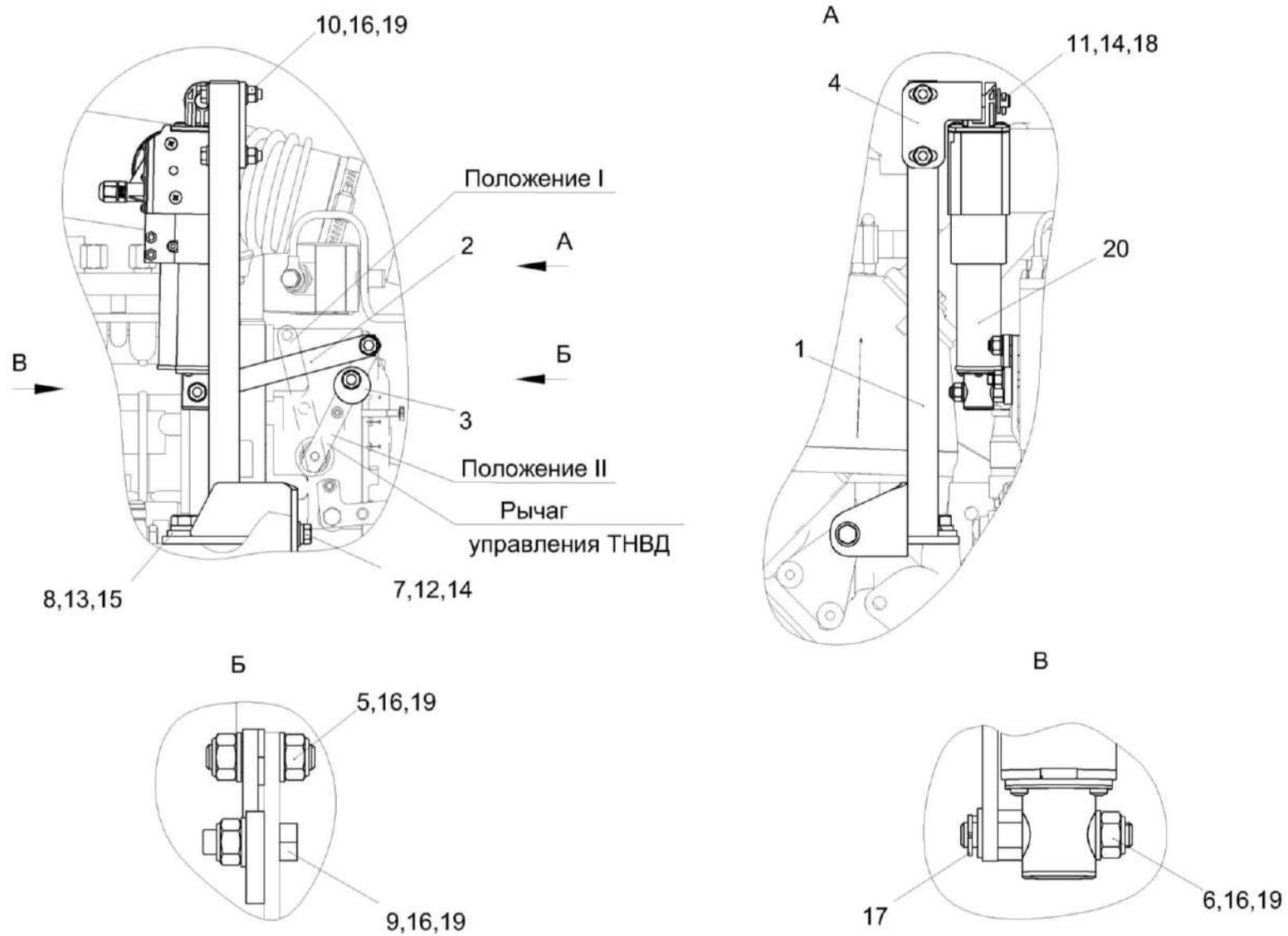
Рисунок 177 – Установка электромеханизма КЗК-8-9-0119640
