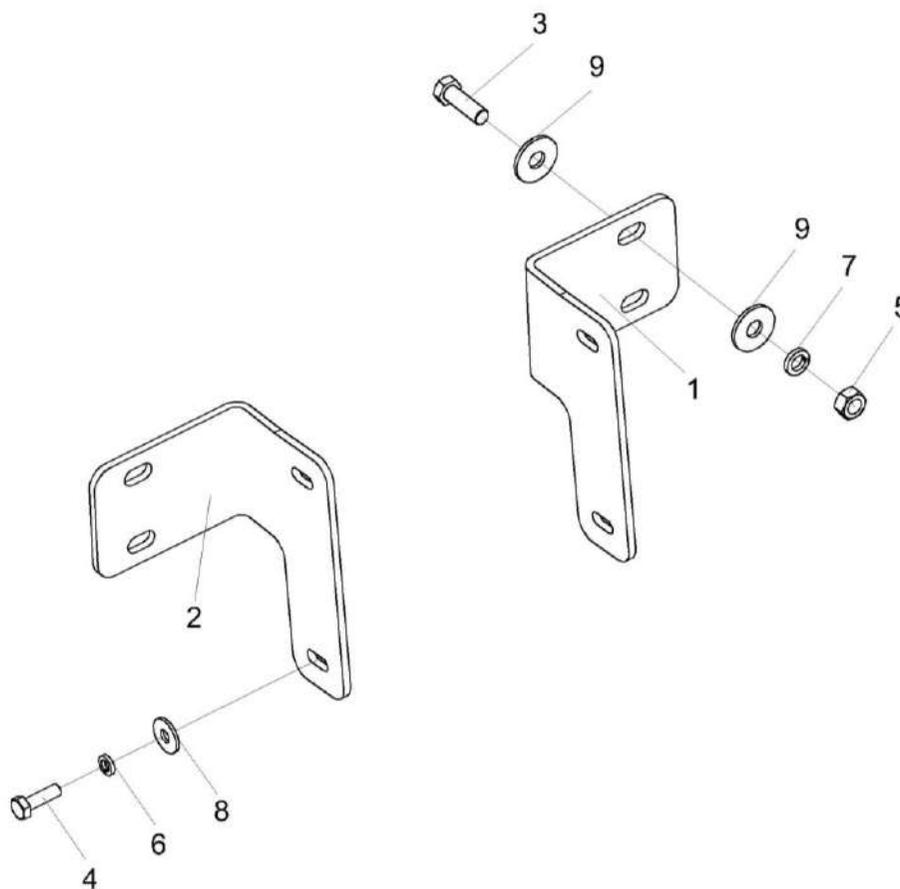
Рисунок 171 – Установка блока испарительно-отопительного КЗК-1420-0113060
