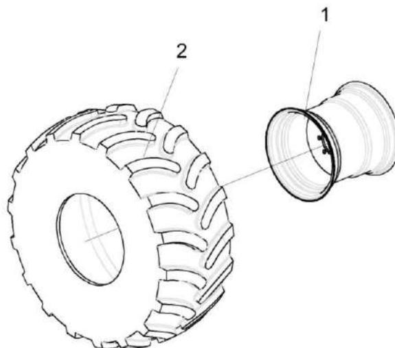
Рисунок 138 – Колесо УЭС-7-0110100 и УЭС-7-0110100-01
