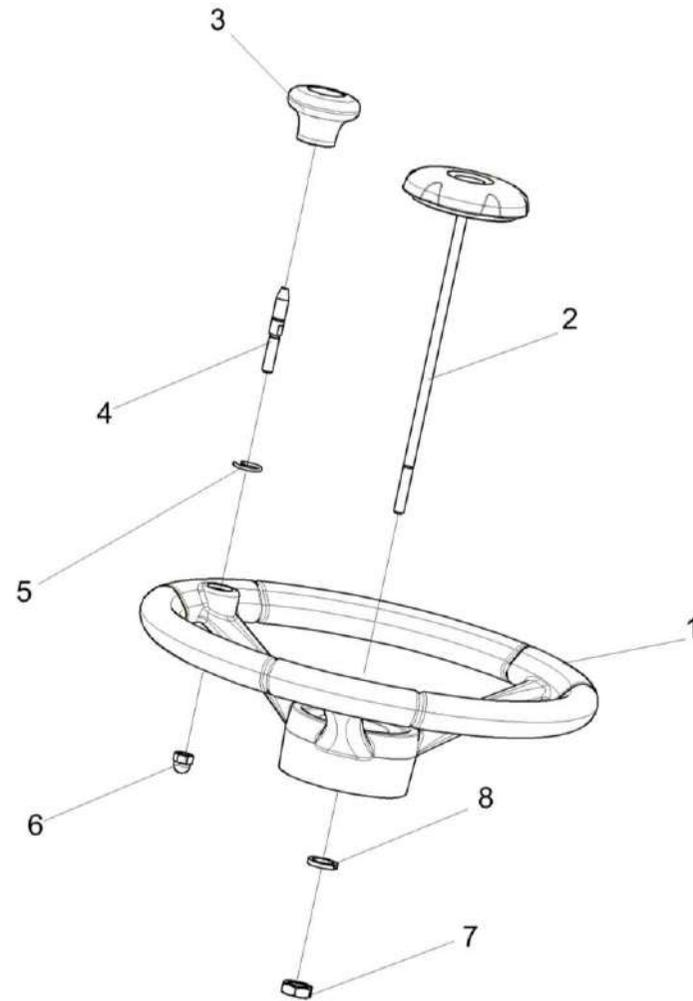
Рисунок 152 – Установка колеса рулевого КЗК-12-0122600-02
