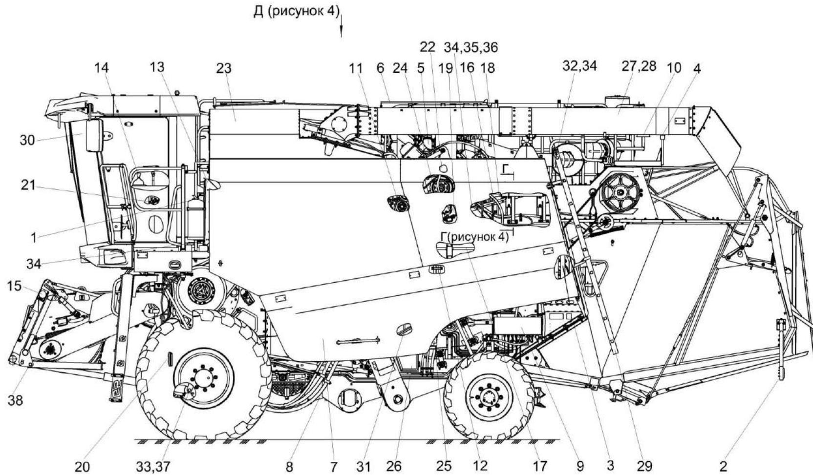
Рисунок 2 – Комбайн зерноуборочный самоходный КЗК-400-1-0100000 и КЗК-400-1-0100000-01 (вид слева)
