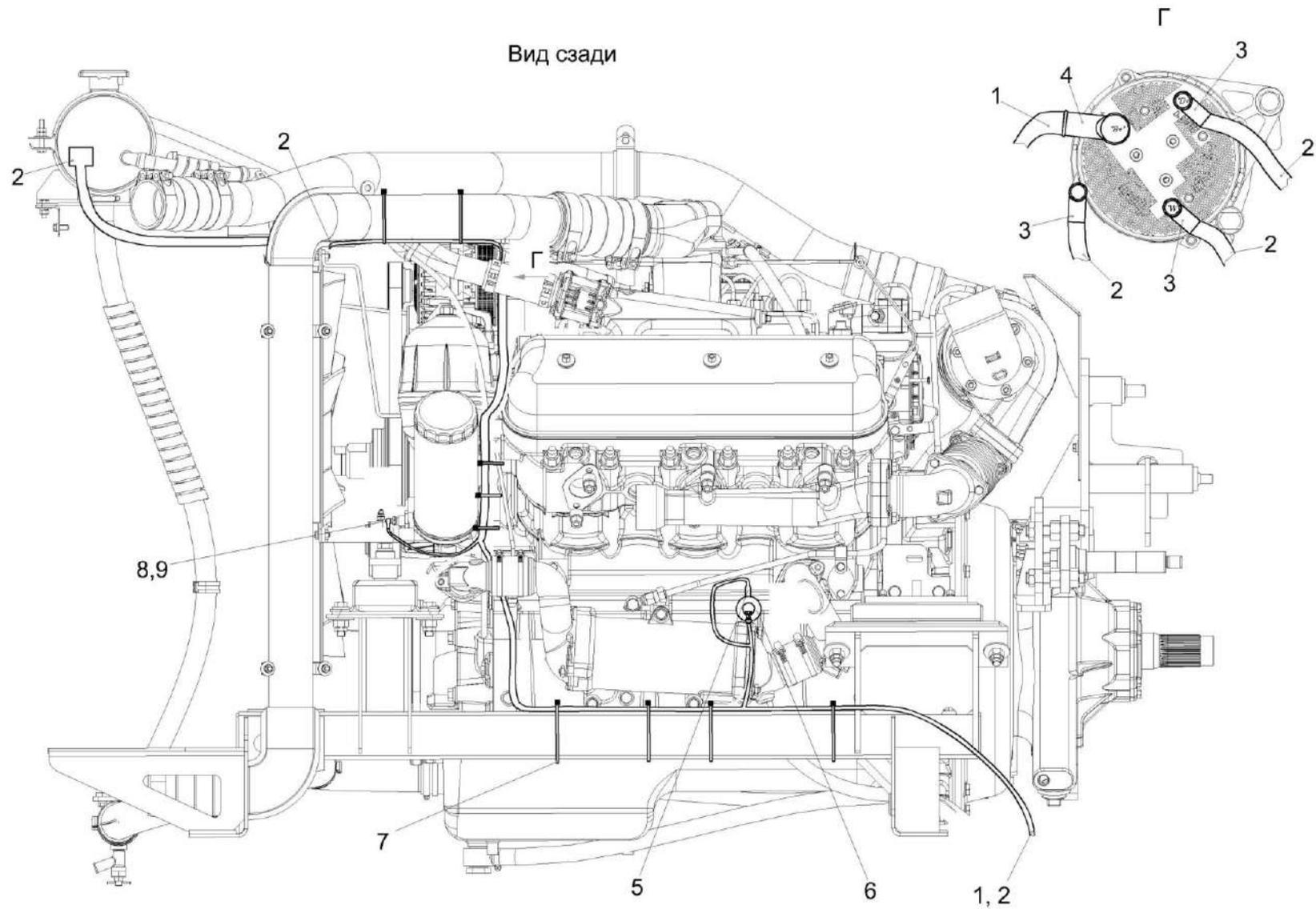
Рисунок 203 – Установка электрооборудования моторной установки КЗК-8-9-0726000 (лист 2)
