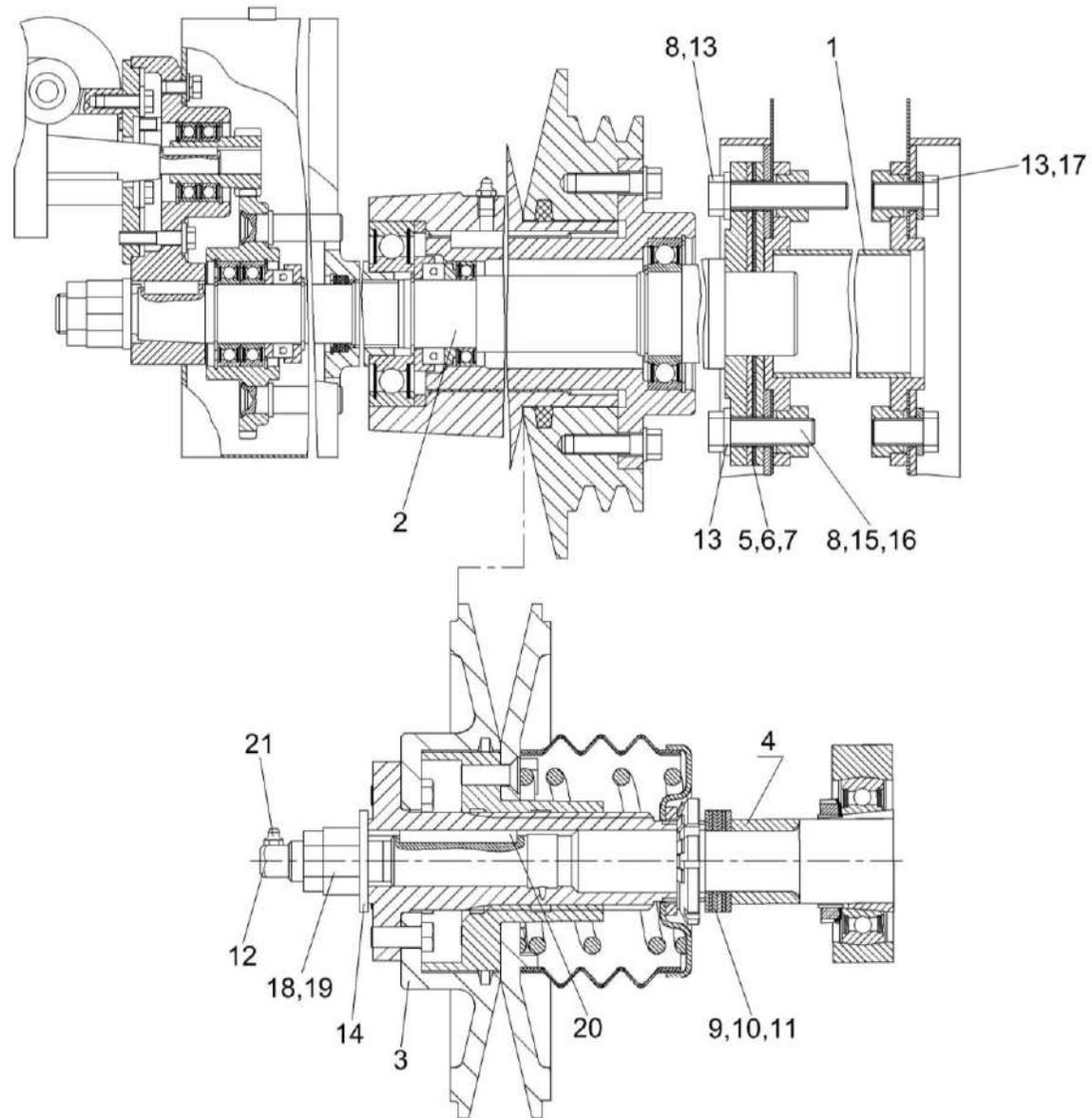
Рисунок 74– Очистка. Шкив ведомый КЗК-12-0217400 и контрпривод вариатора КЗК-7-0202500Б
