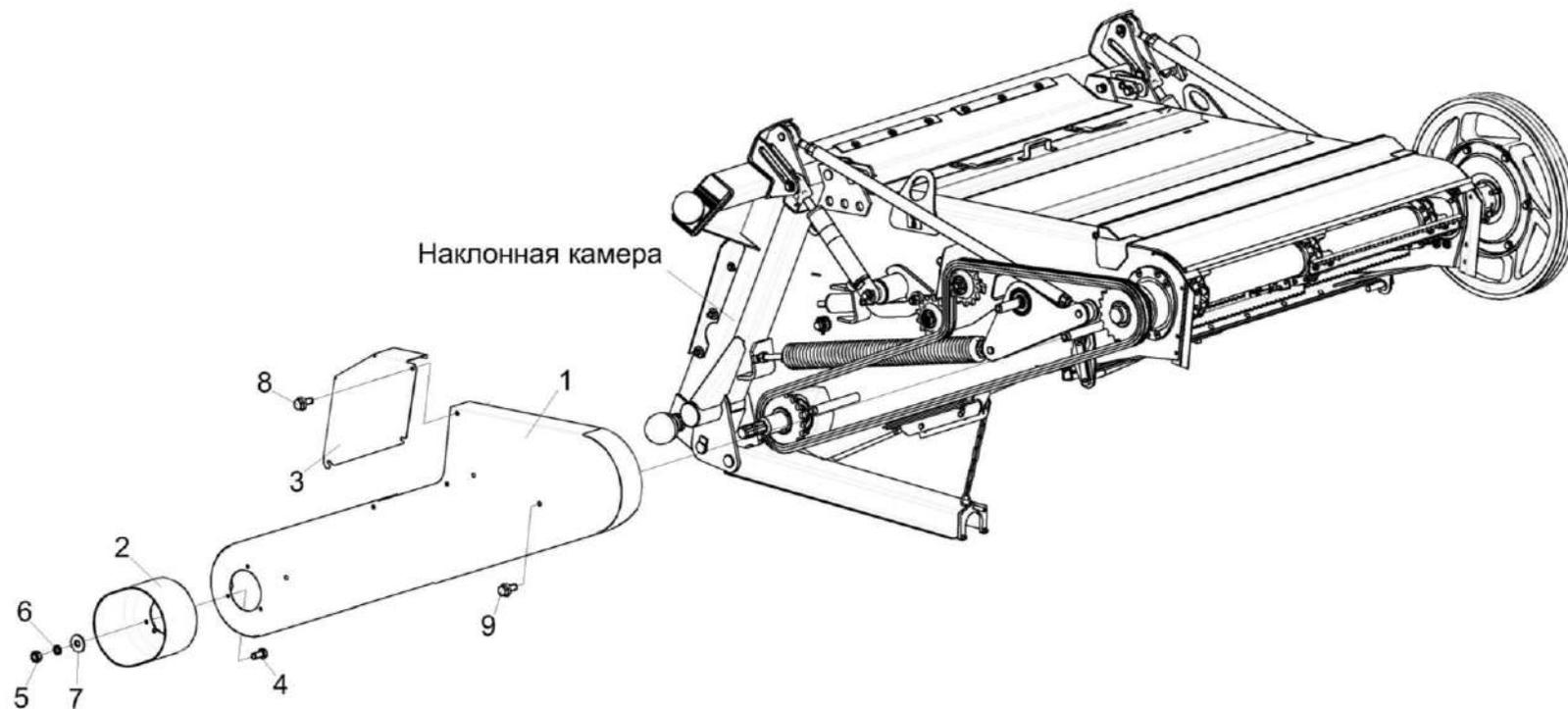
Рисунок 8 – Установка ограждения КЗК-8-8-1800060 и КЗК-8-8-1800070
