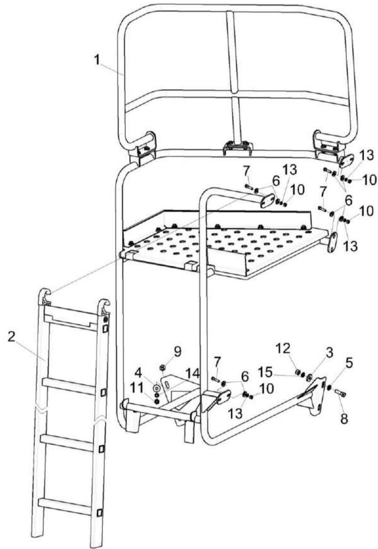
Рисунок 228 – Установка лестницы КЗК-400-1-0100250
