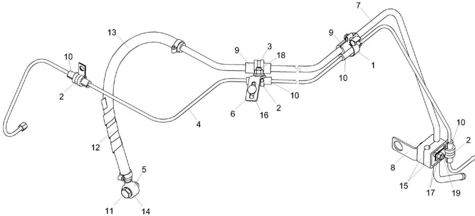
Рисунок 198 – Установка топливопроводов КЗК-8-9-0126100
