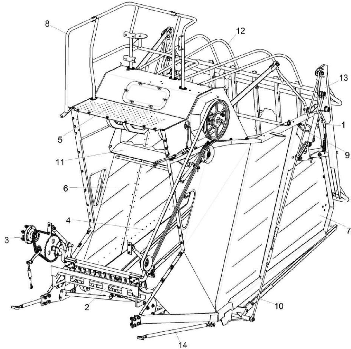
Рисунок 110 – Установка копнителя КЗК-400-1-0400000 (общий вид)
