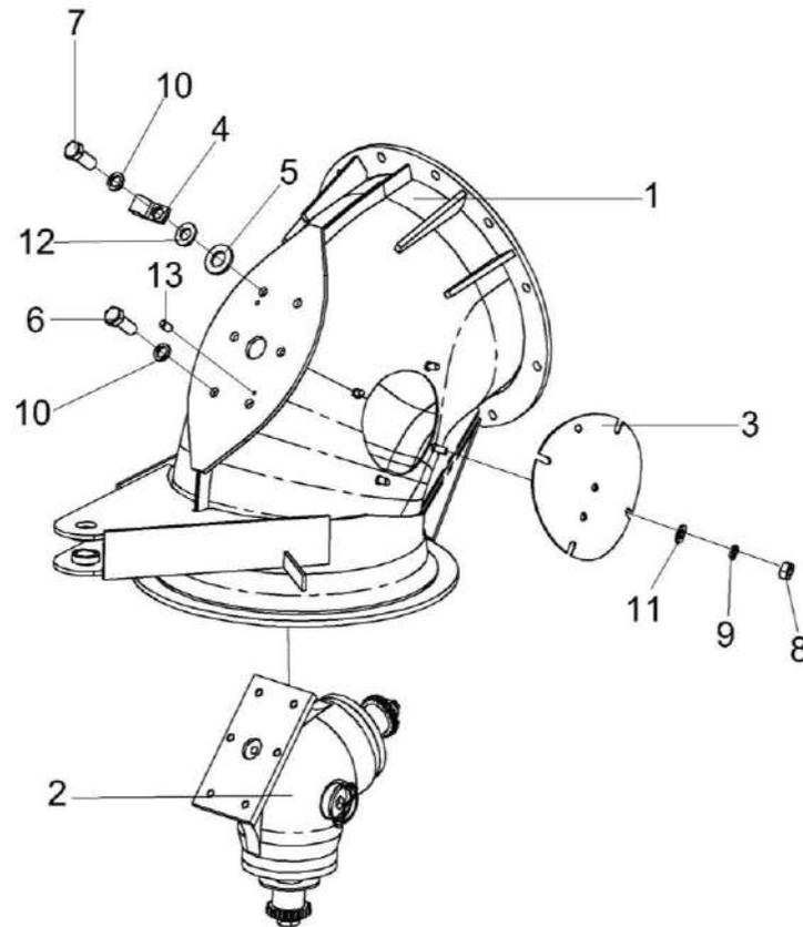
Рисунок 107 – Отвод с редуктором КЗК-810-0206020
