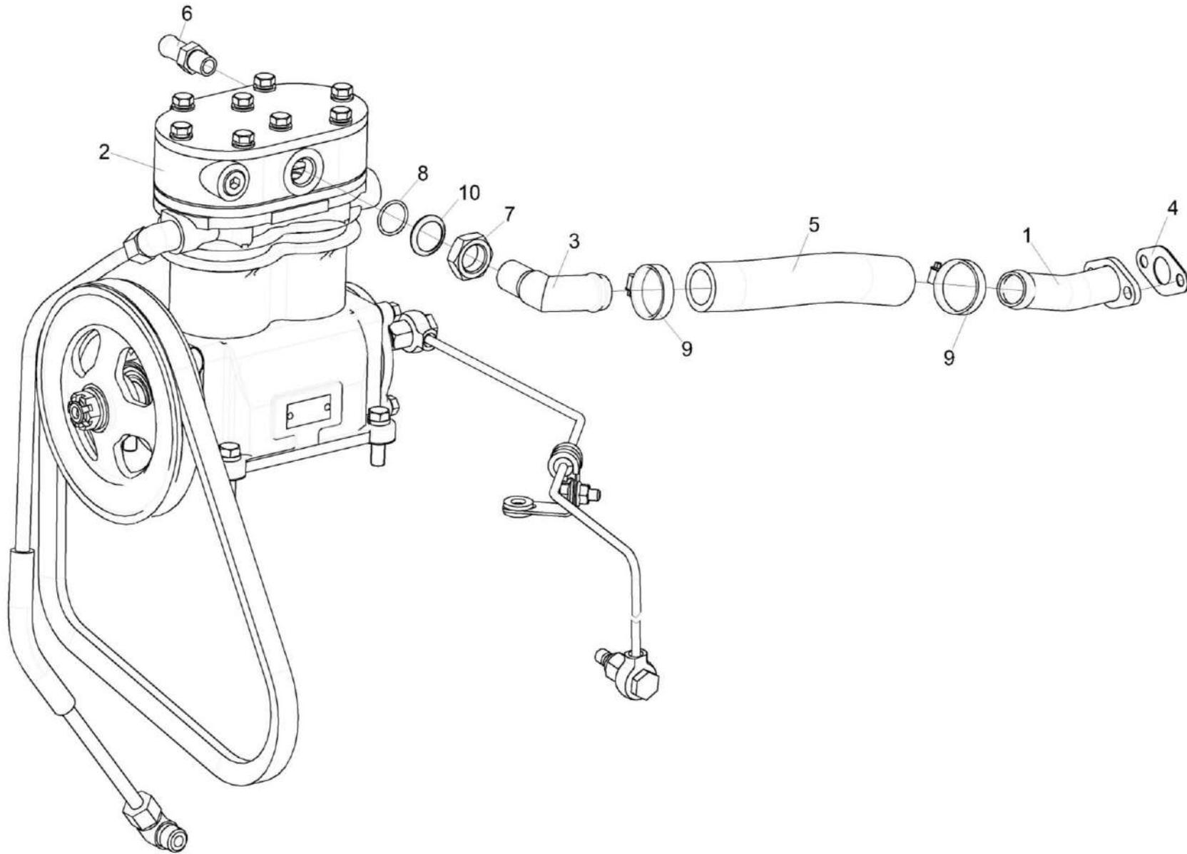
Рисунок 196 – Подключение компрессора КЗК-8-9-0106900
