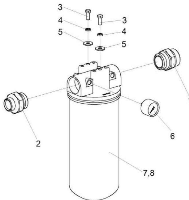
Рисунок 282 – Фильтр сливной КЗК-8-9-0602300
