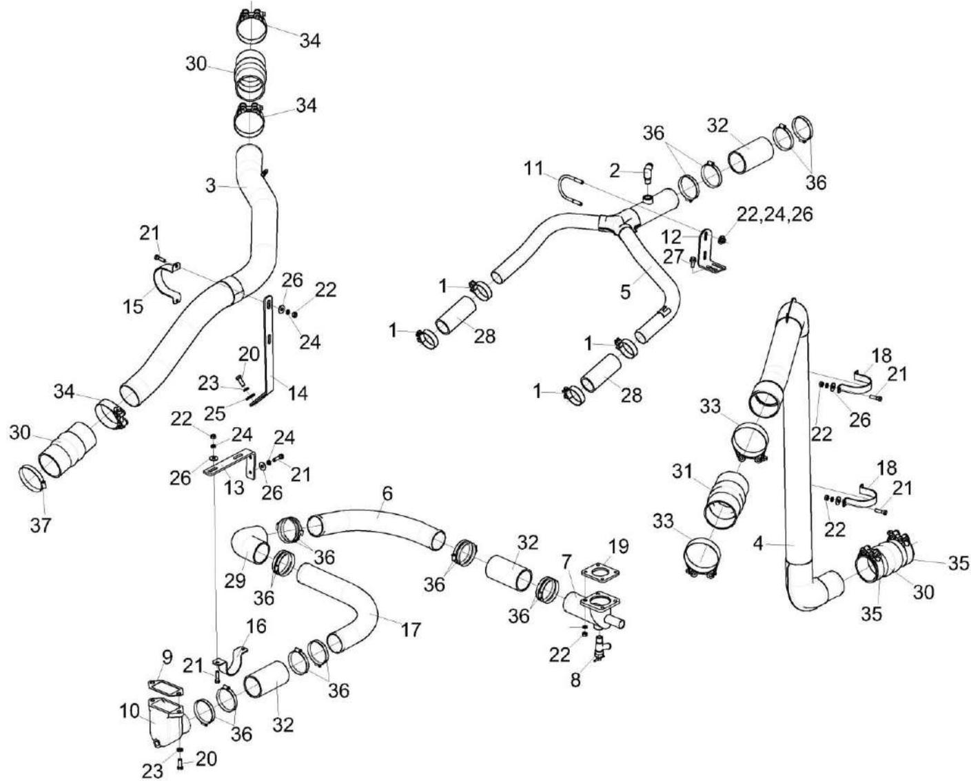
Рисунок 194 – Установка труб КЗК-8-9-0106100
