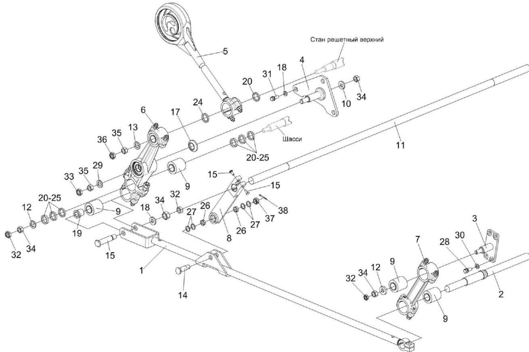
Рисунок 71 – Установка привода доски стрясной КЗК 0280000А (вид справа)
