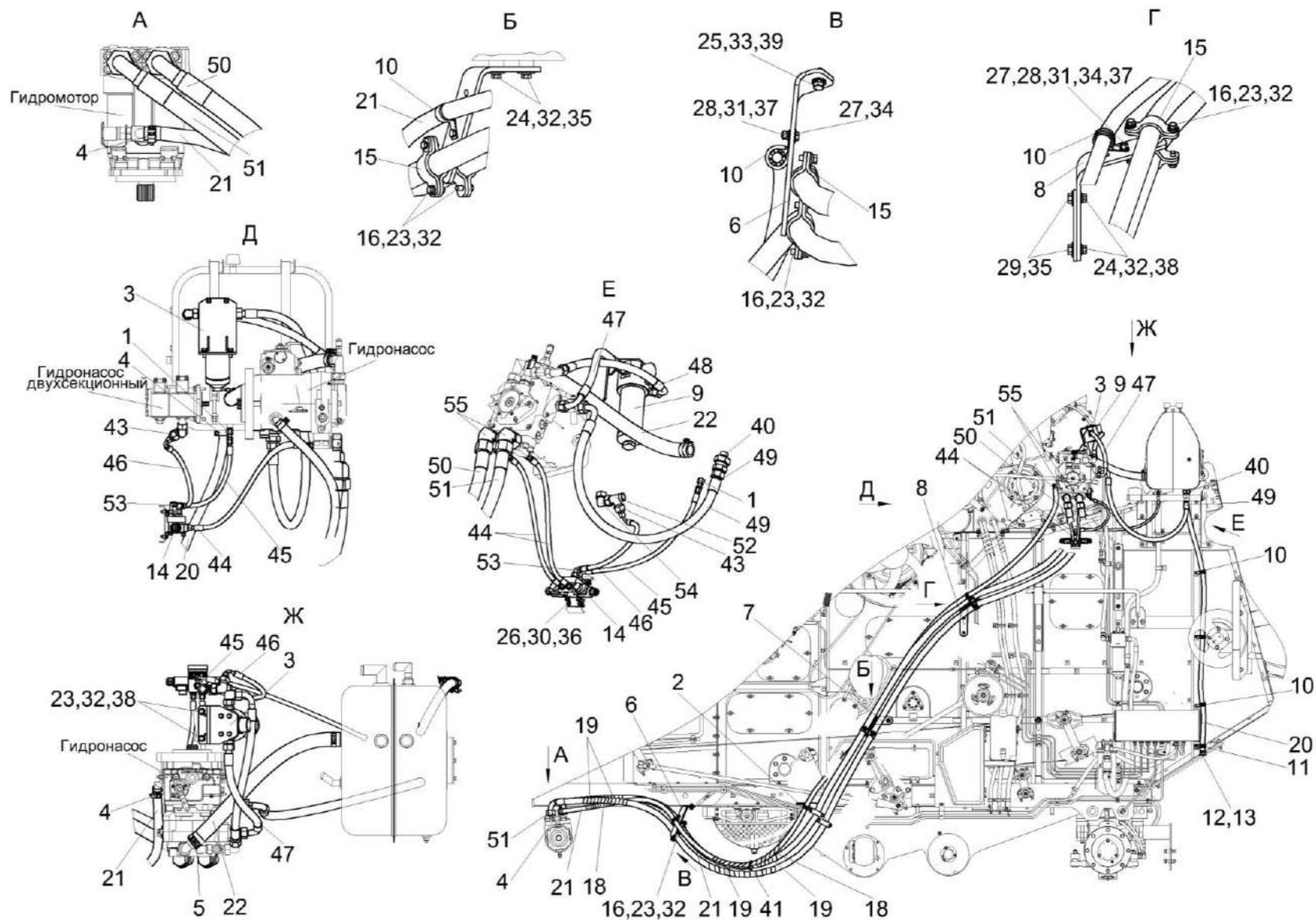
Рисунок 266 – Гидросистема привода ходовой части КЗК-8-9-0601000
