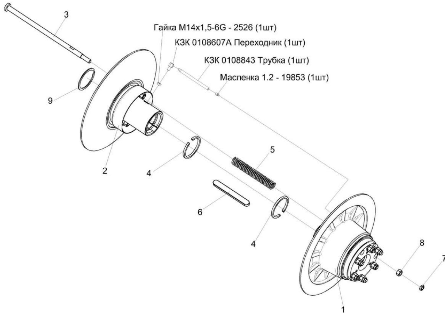
Рисунок 13 – Вариатор барабана КЗК 0108100-01 и КЗК 0108350-01
