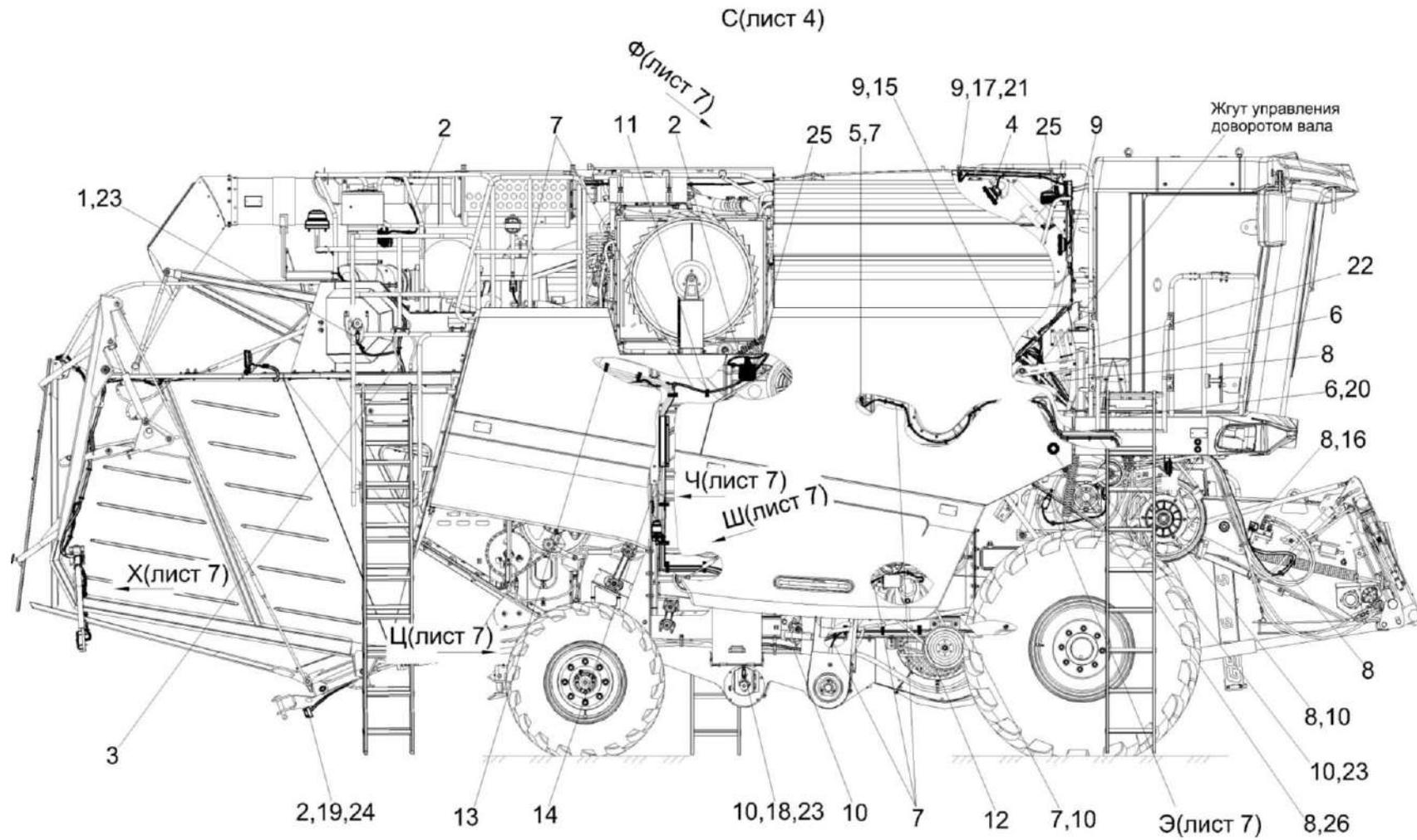
Рисунок 254 – Установка электрооборудования комбайна КЗК-400-1-0721000 (лист 6)
