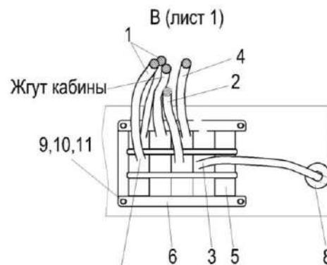
Рисунок 258 – Установка электрооборудования пульта управления КЗК-400-1-0725000 (лист 3)
