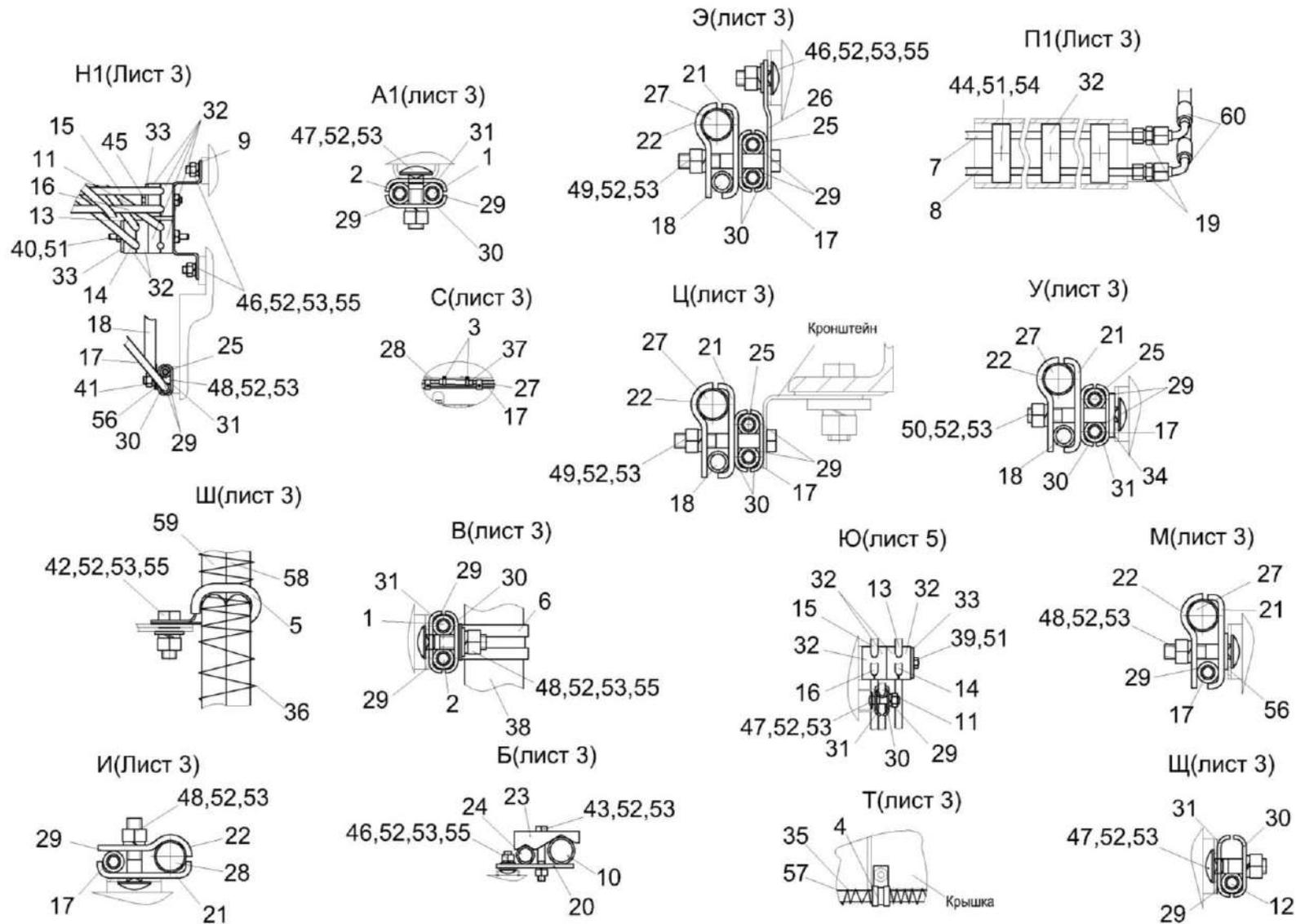
Рисунок 276 – Гидросистема рулевого управления и силовых гидроцилиндров КЗК-400-1-0602000 (лист 5)
