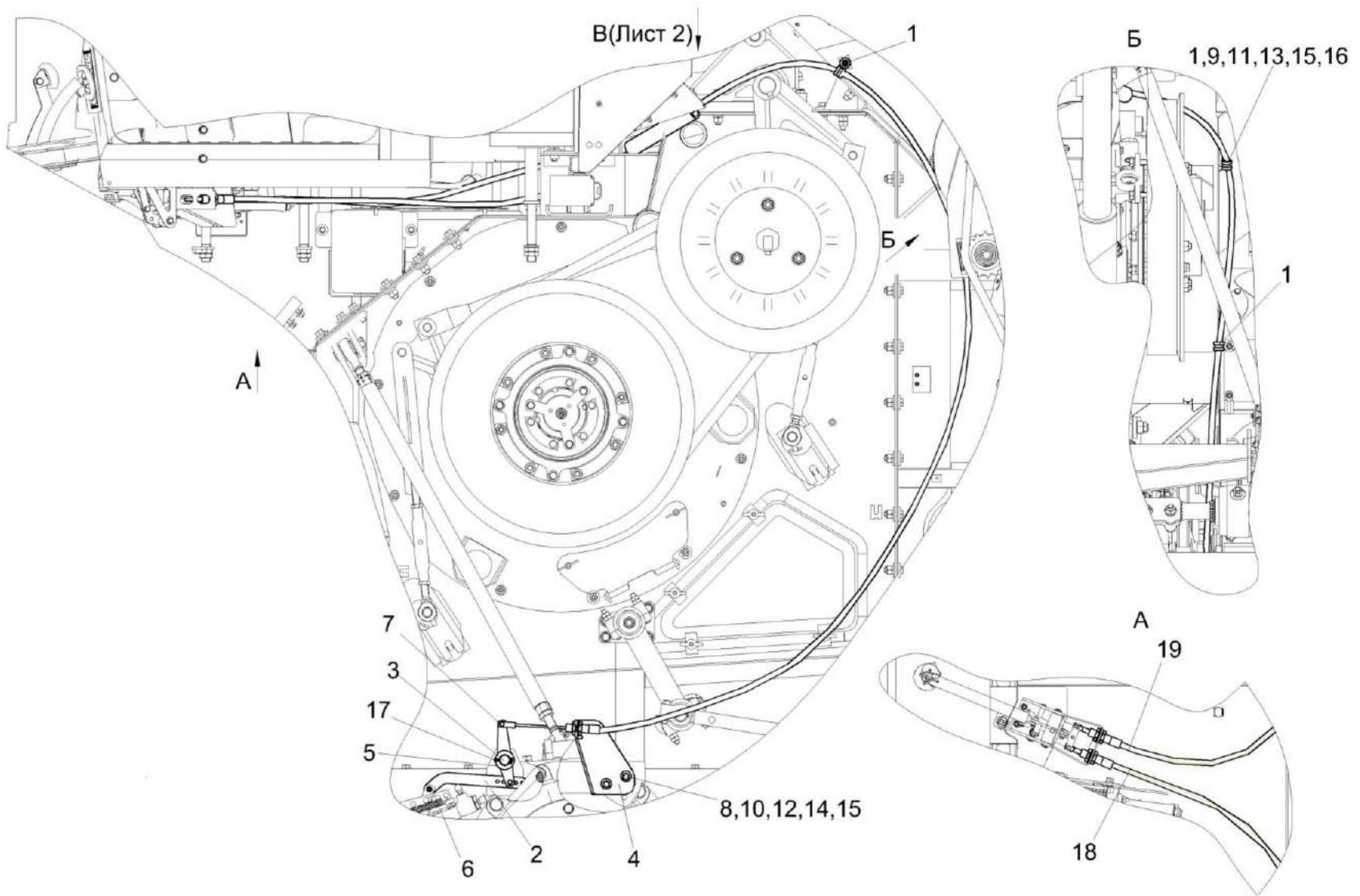
Рисунок 173 – Установка тросов управления стояночным тормозом КЗК-8-9-0119610 (лист 1)
