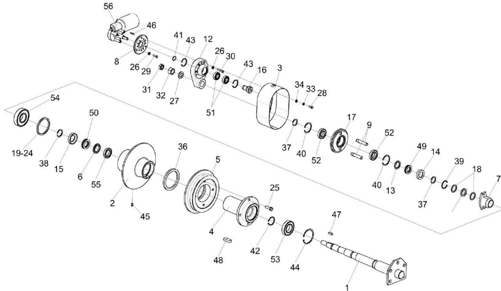
Рисунок 76 – Контрпривод вариатора КЗК-7-0202500Б
