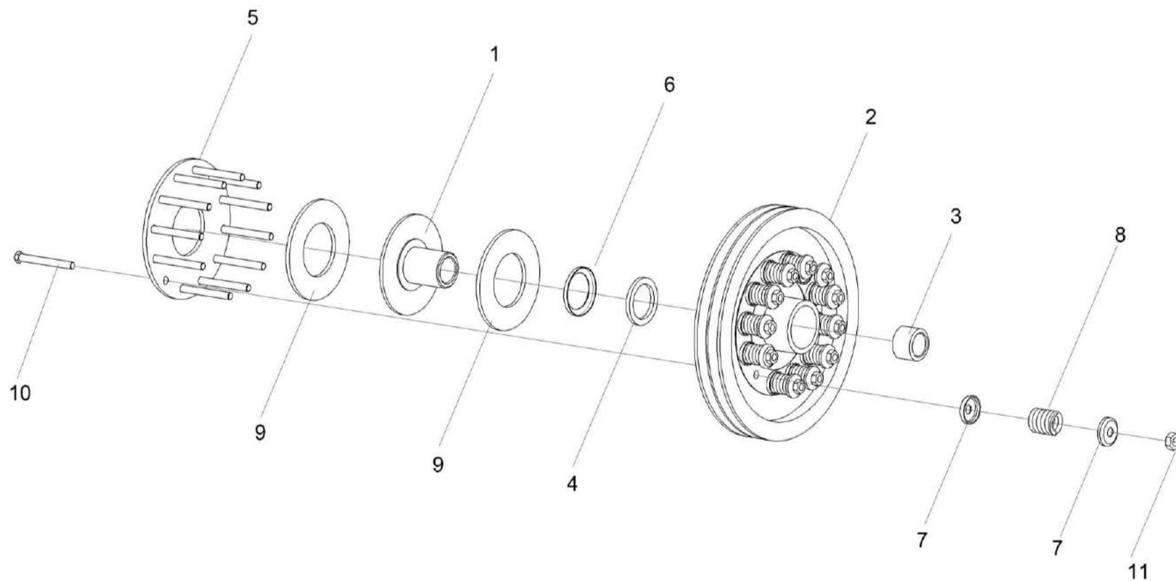
Рисунок 102 – Муфта фрикционная КЗК 0219100А
