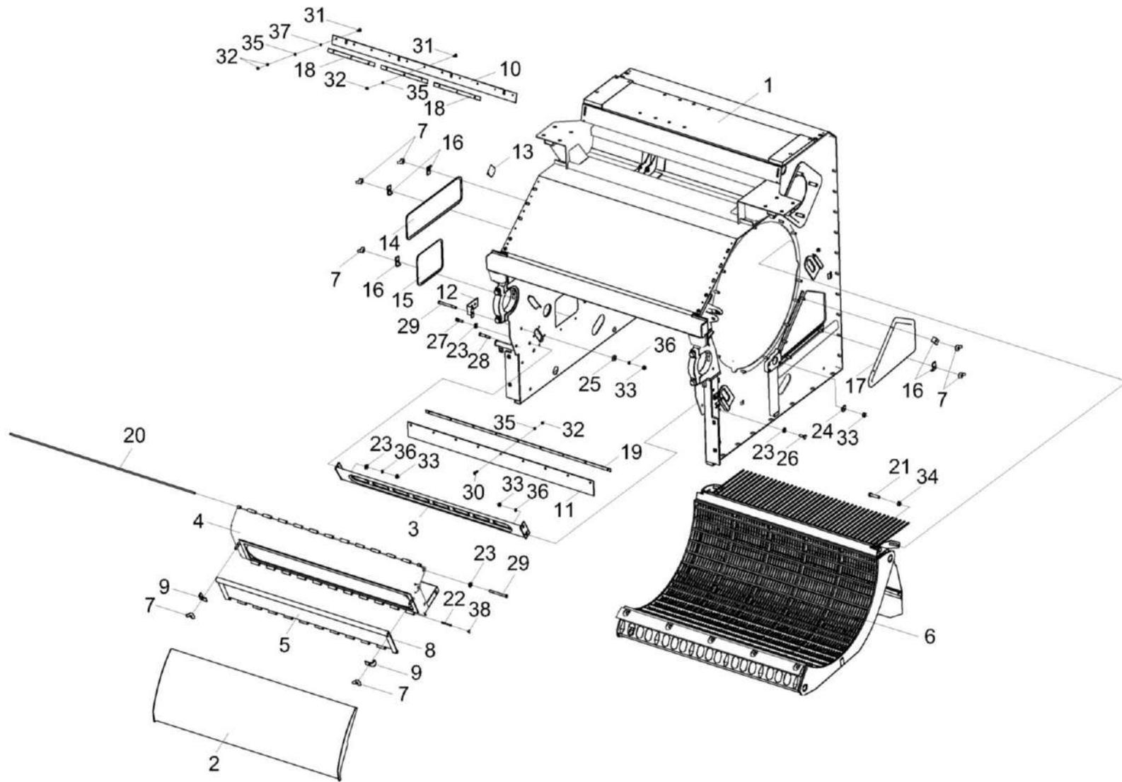
Рисунок 18 - Аппарат молотильный КЗК-8-9-1-0102000 (установка камнеуловителя и подбарабанья)
