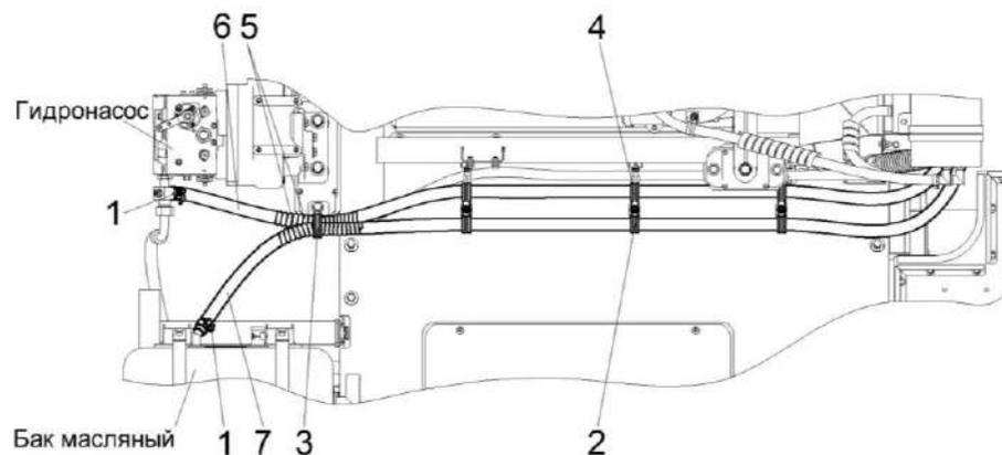
Рисунок 271 – Установка рукавов радиатора КЗК-8-9-0601700
