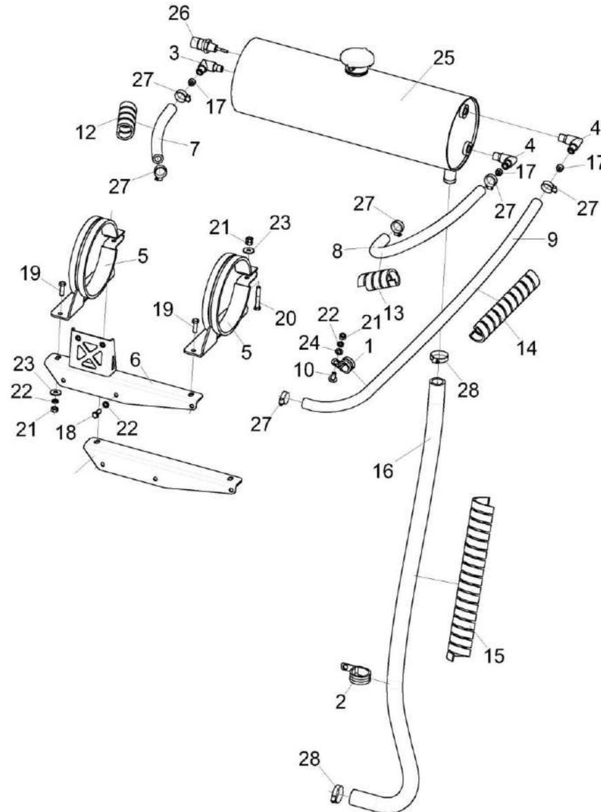
Рисунок 193 – Установка бачка расширительного КЗК-8-9-0106070
