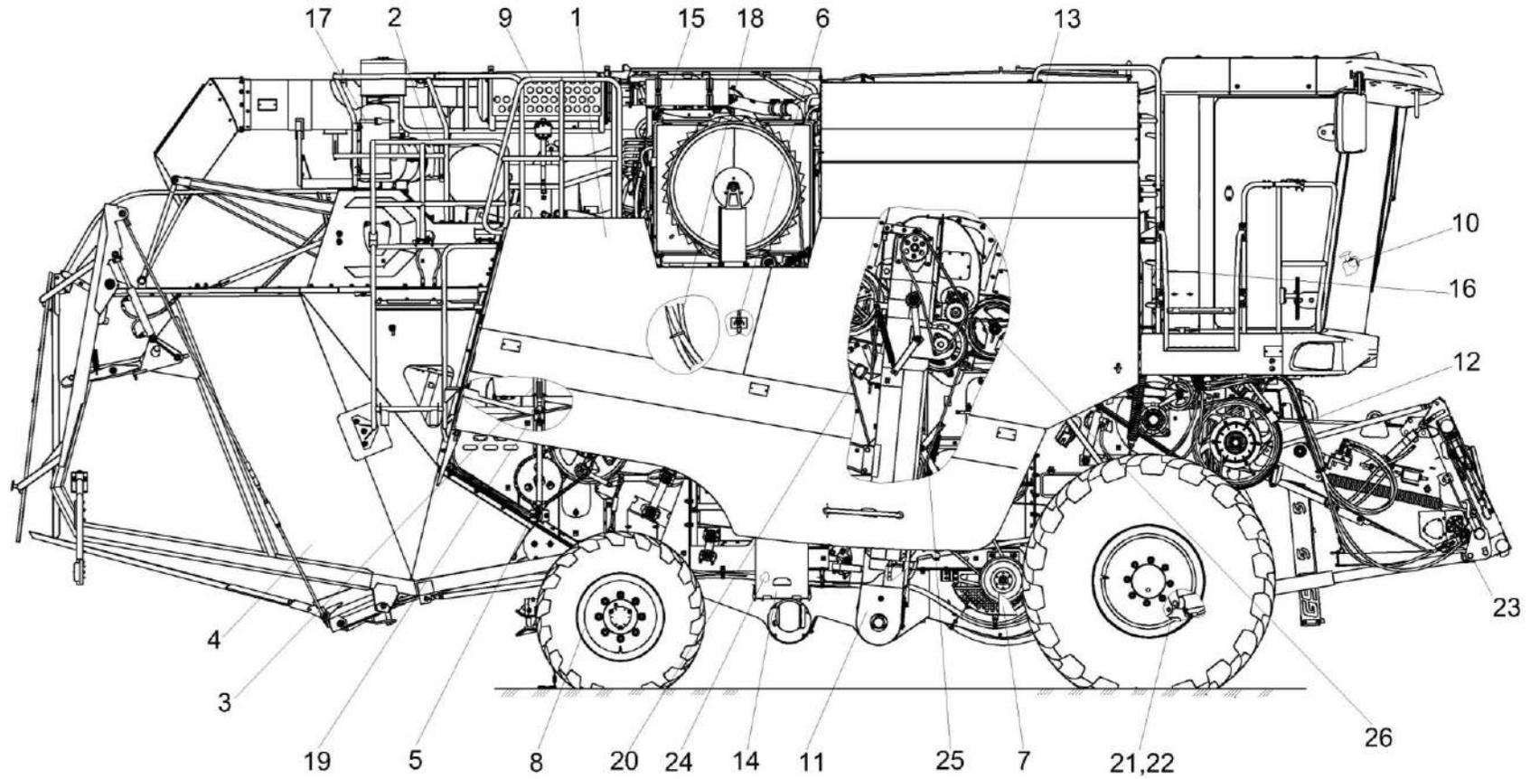
Рисунок 3 – Комбайн зерноуборочный самоходный КЗК-400-1-0100000 и КЗК-400-1-0100000-01 (вид справа)
