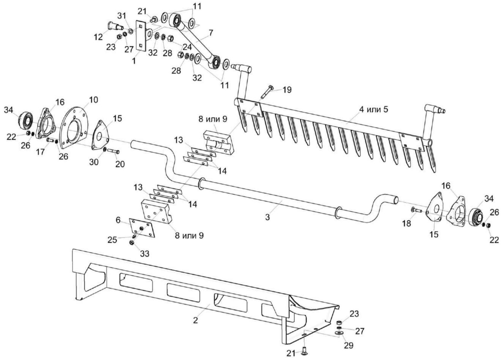
Рисунок 113 – Установка половонабивателя КЗК-400-1-0400010
