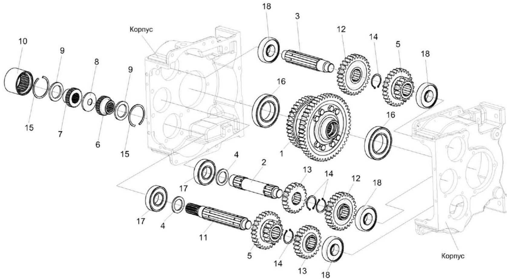
Рисунок 39 – Коробка передач КЗК-8-4-0107030 (валы, шестерни)
