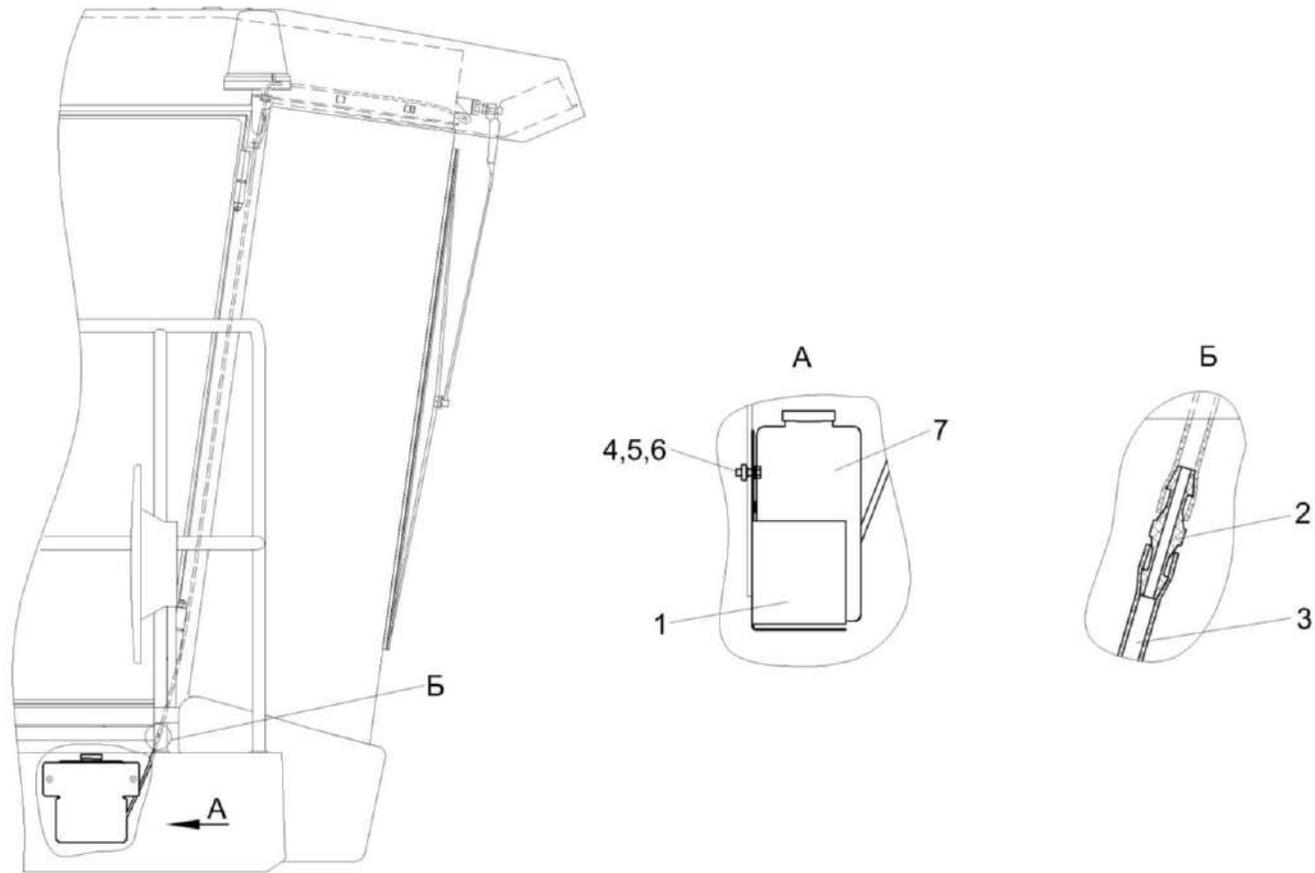
Рисунок 164 – Установка стеклоомывателя КЗК-12-0120460
