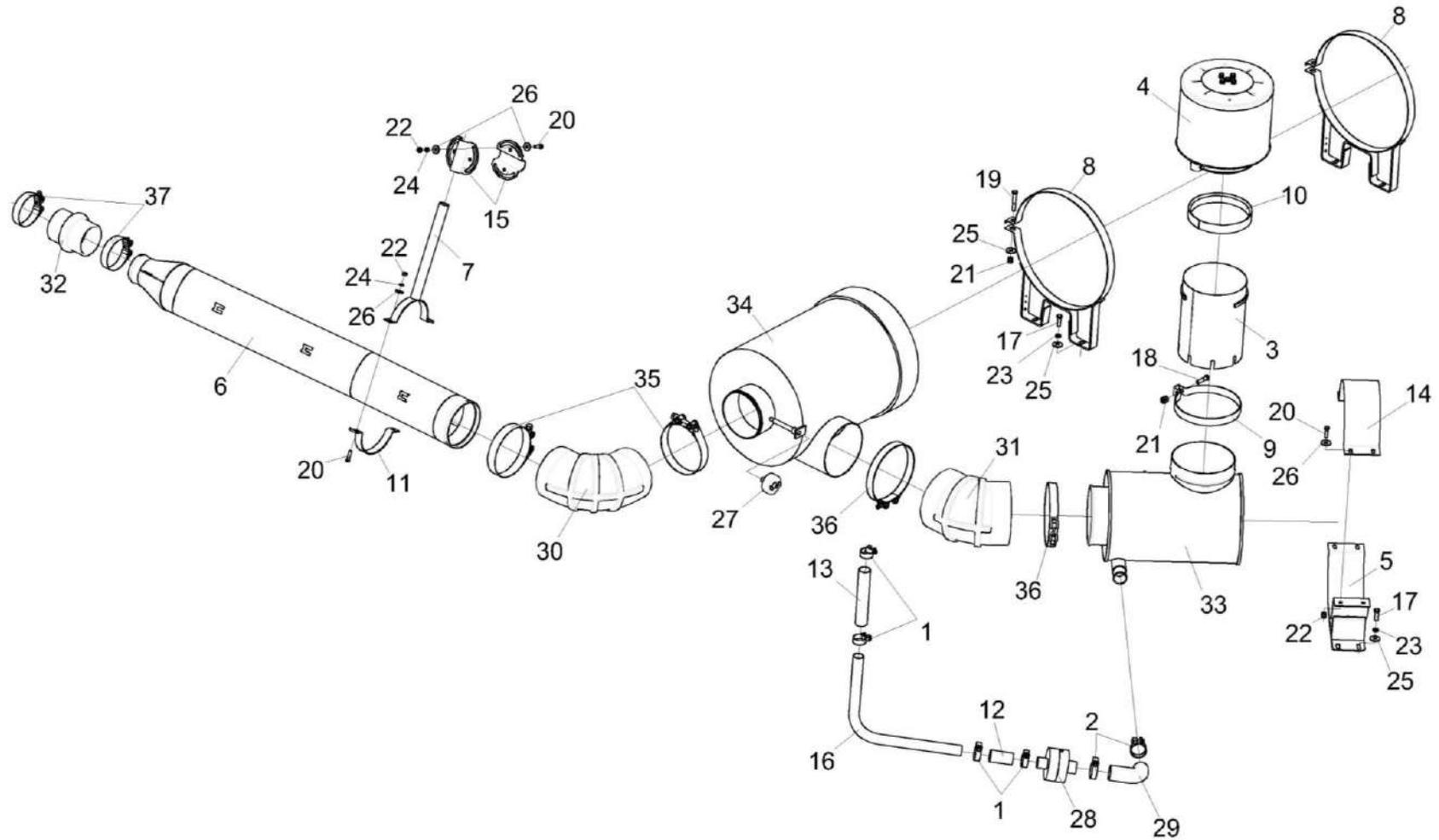
Рисунок 201 – Установка воздухоочистителя КЗК-400-1-0106080
