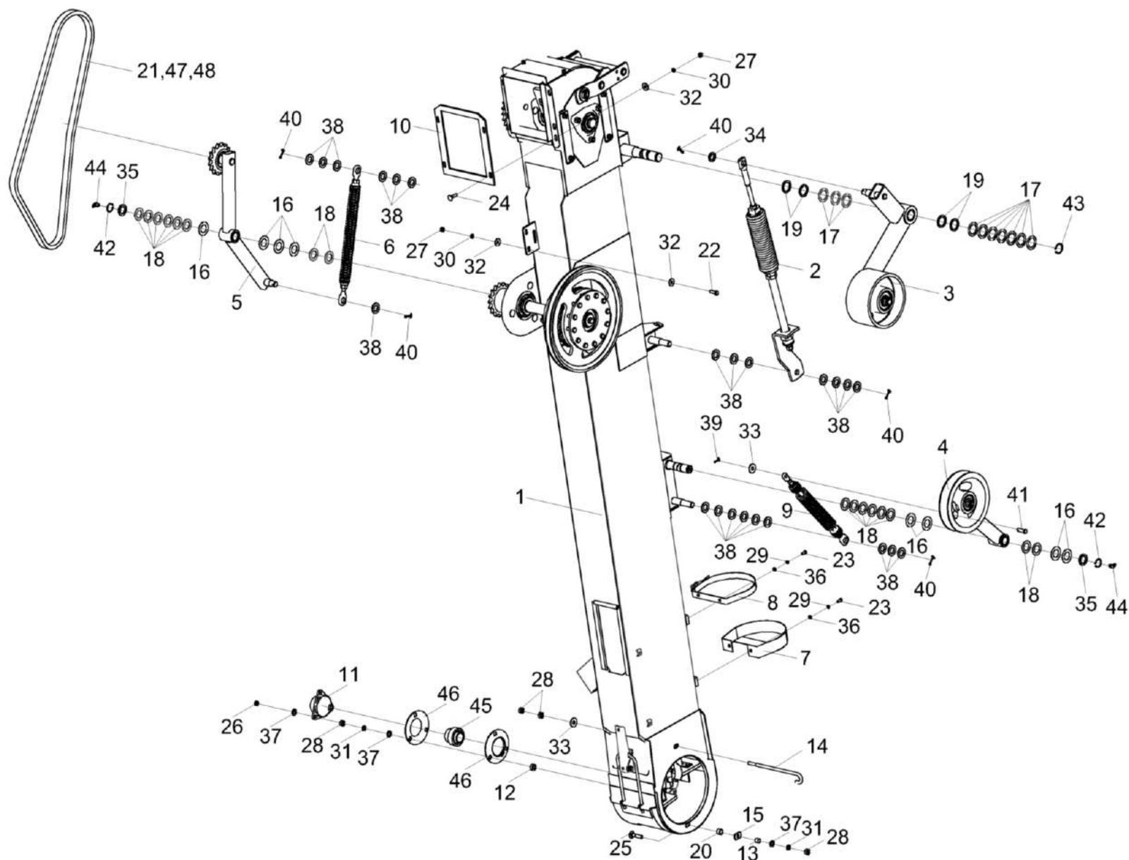
Рисунок 95 - Установка элеватора КЗК-8-9-0214000
