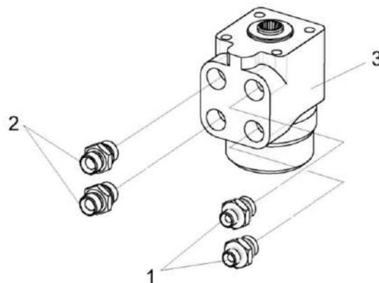
Рисунок 288 – Насос-дозатор КЗК-8-9-0602100
