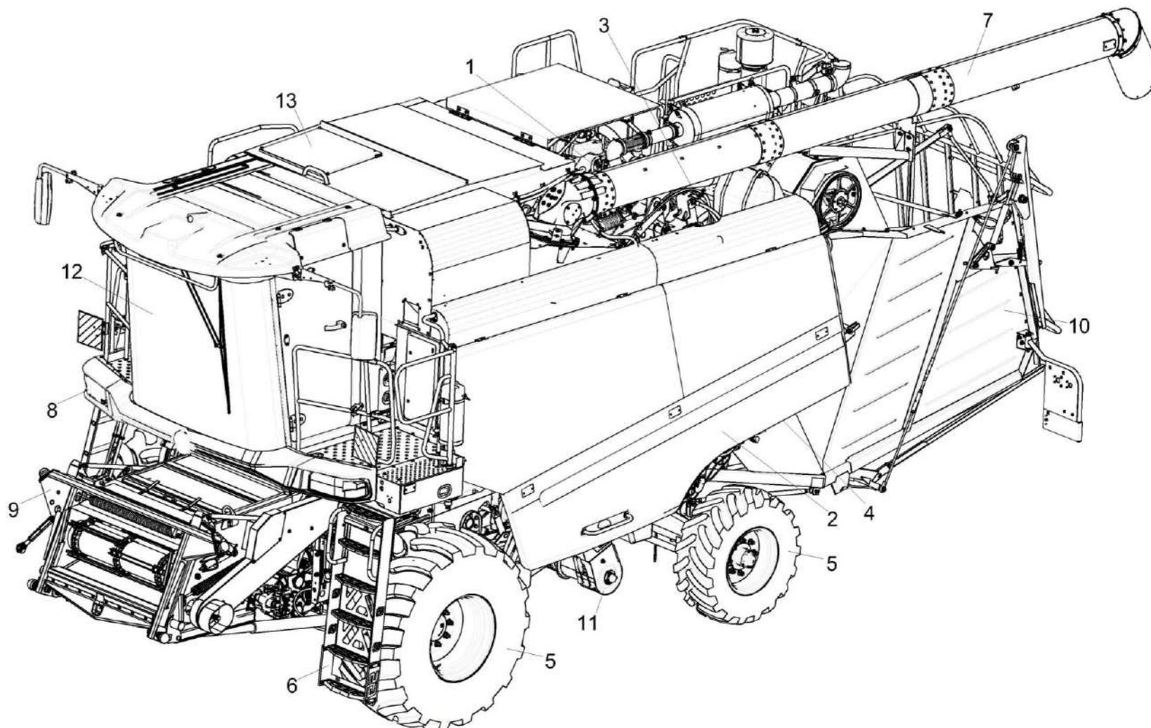
Рисунок 1 – Комбайн зерноуборочный самоходный КЗК-400-1-0100000 и КЗК-400-1-0100000-01 (общий вид)
