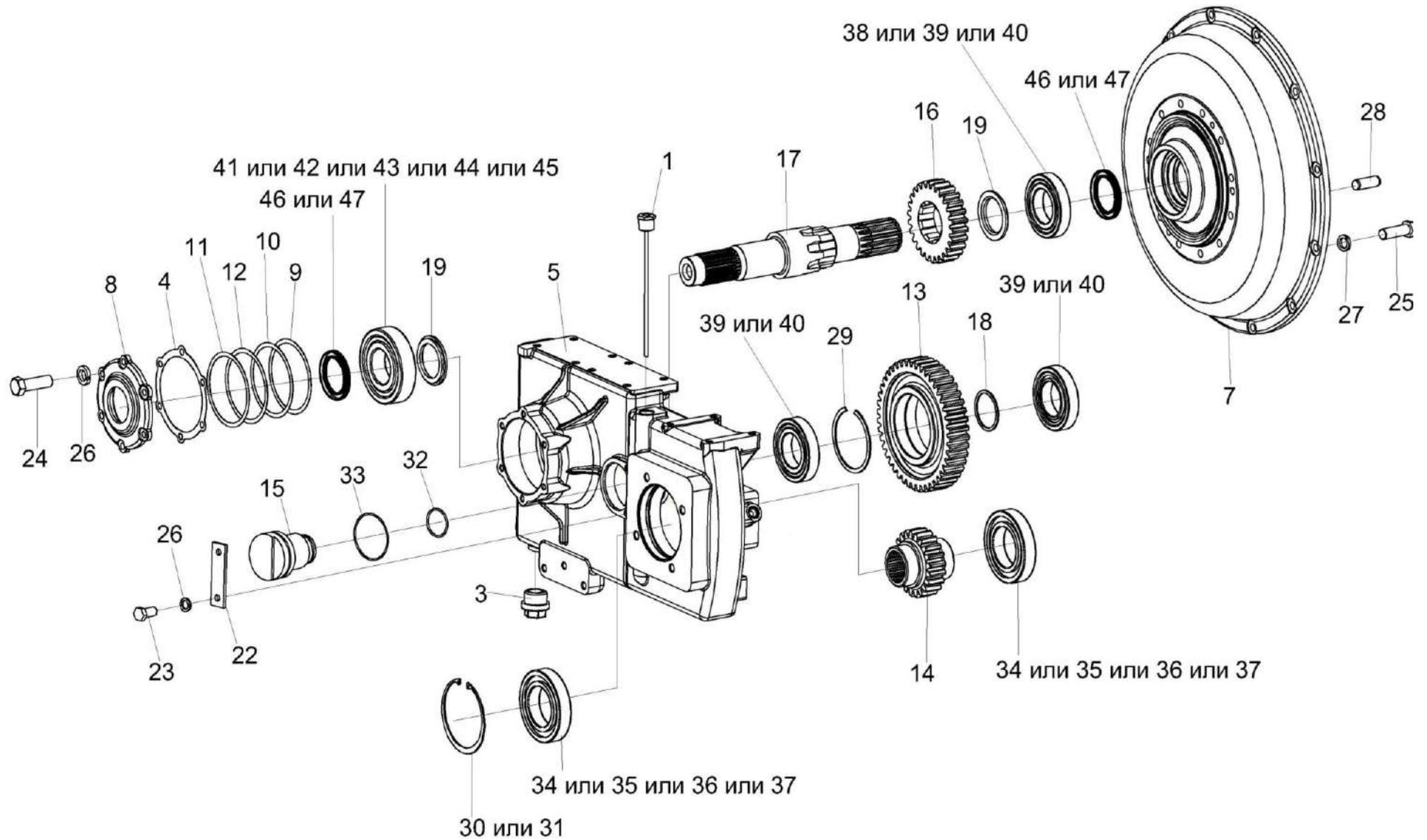
Рисунок 185 – Мультипликатор КЗК-12-0114100-08
