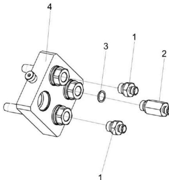
Рисунок 289 – Разъем многофункциональный КЗК-8-8-0602350
