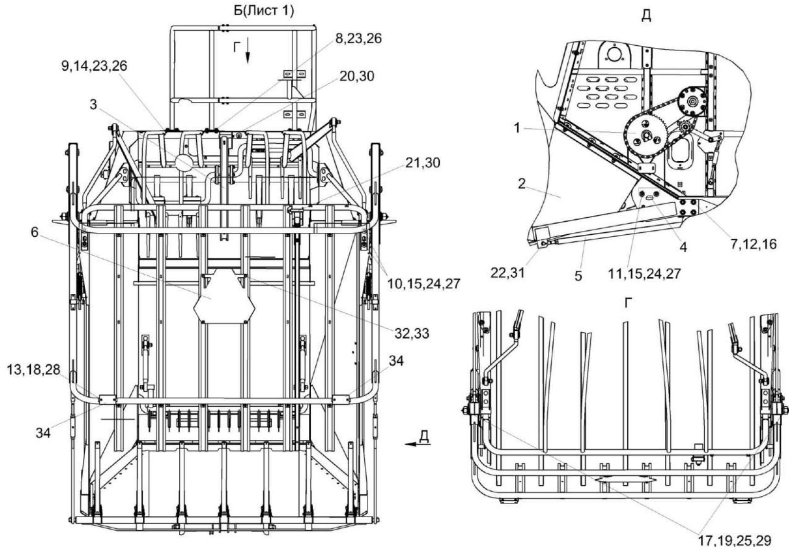
Рисунок 112 – Установка копнителя КЗК-400-1-0400000 (лист 2)
