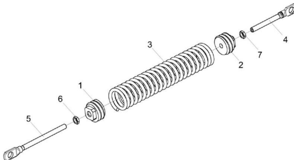
Рисунок 209 - Пружина КЗК-200-0220110
