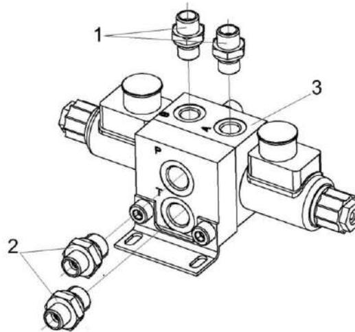
Рисунок 279 – Гидроблок доворота вала мотора ГСТ УЭС-16-0601060
