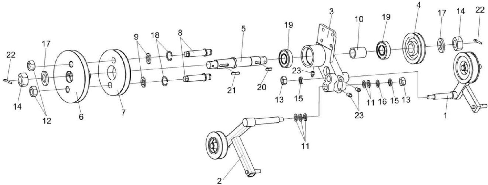
Рисунок 191 – Контрпривод КЗК 0112080А
