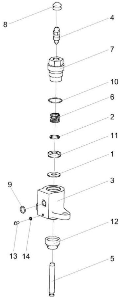
Рисунок 42 – Гидроцилиндр КЗК-12-0107200-01
