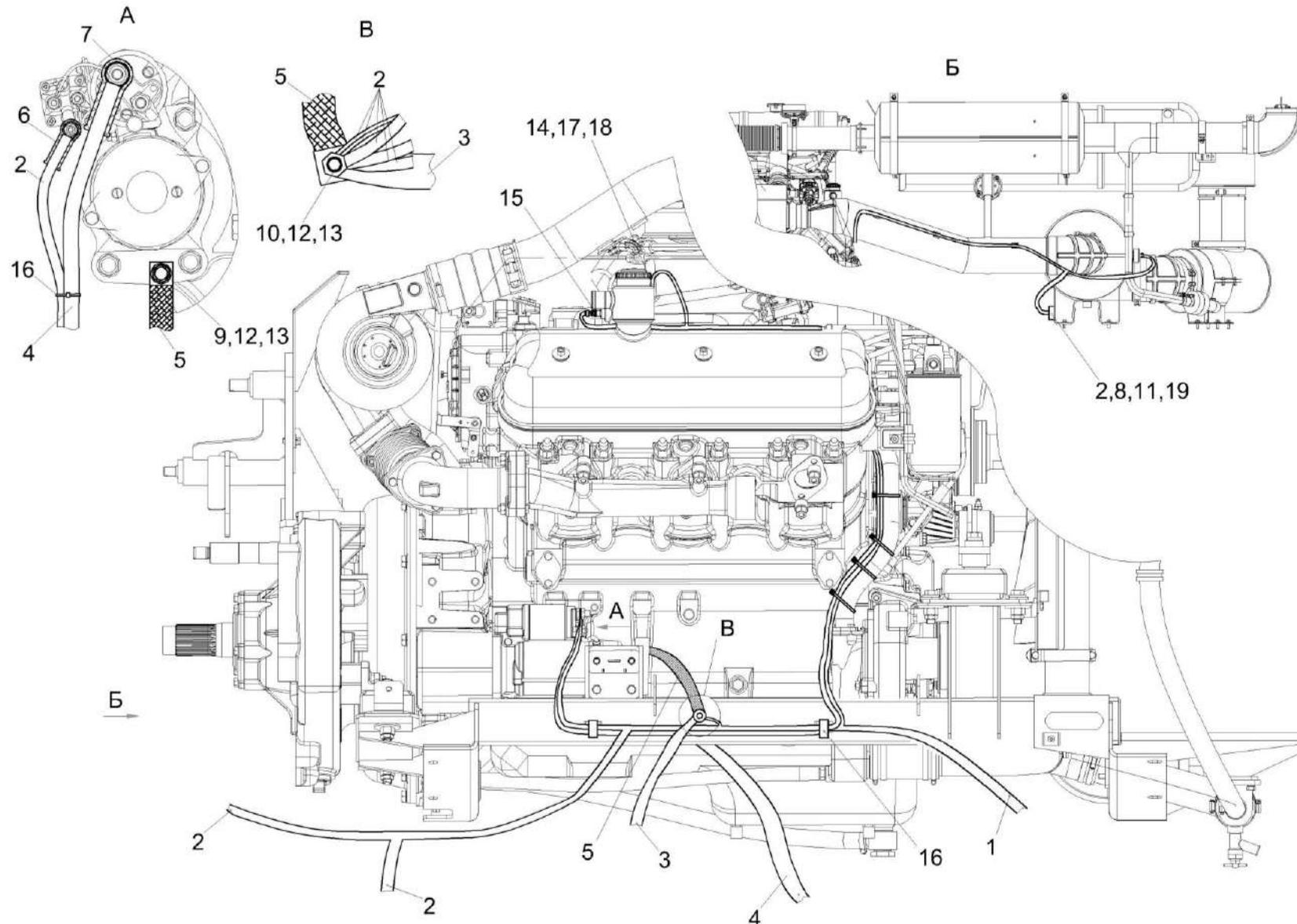
Рисунок 202 – Установка электрооборудования моторной установки КЗК-8-9-0726000 (лист 1)
