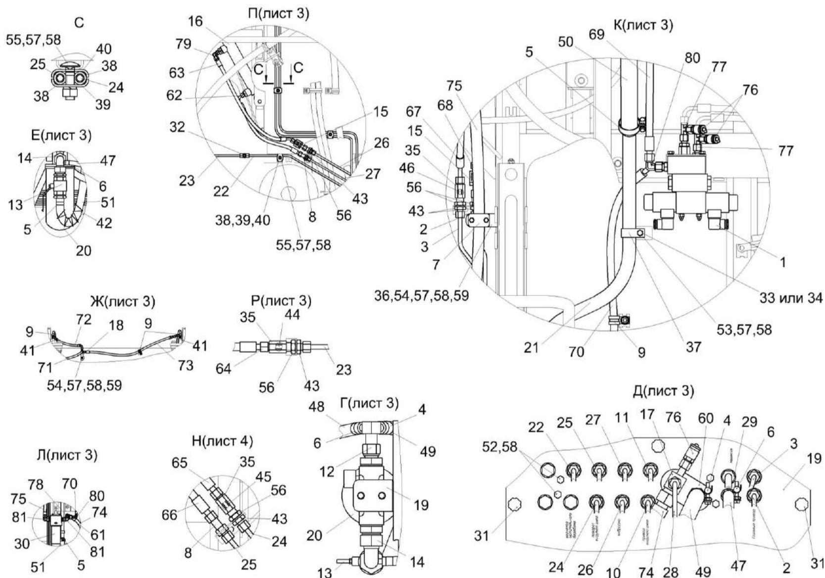
Рисунок 275 – Гидросистема рулевого управления и силовых гидроцилиндров КЗК-400-1-0602000 (лист 4)
