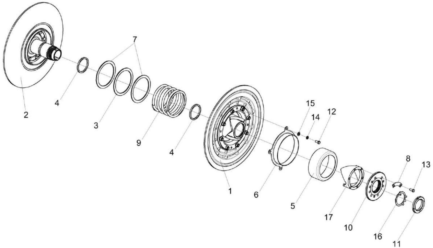
Рисунок 14 – Вариатор барабана КЗК 0123000 и КЗК 0123300
