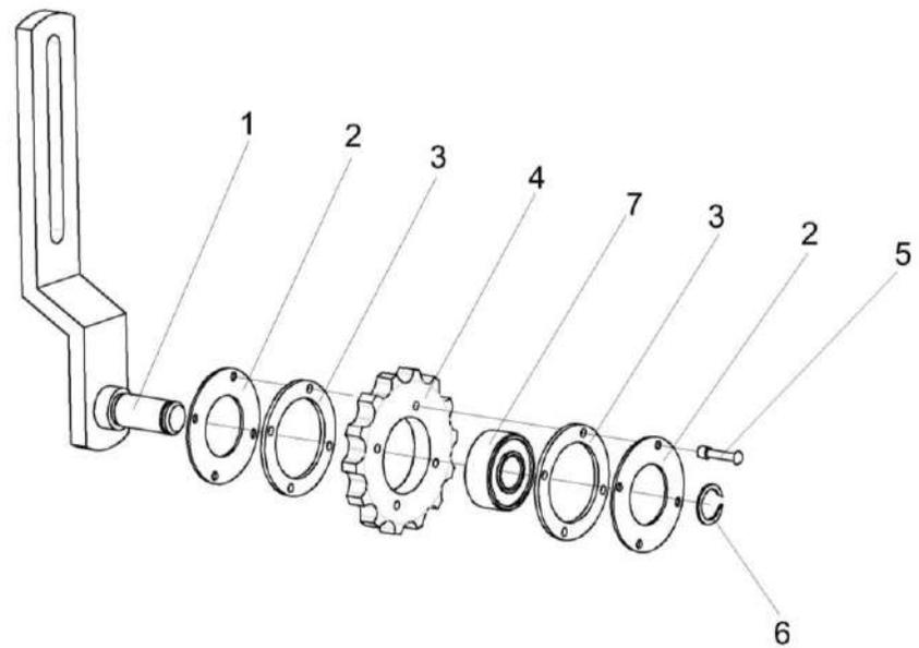
Рисунок 68 – Устройство натяжное КЗР 0202480
