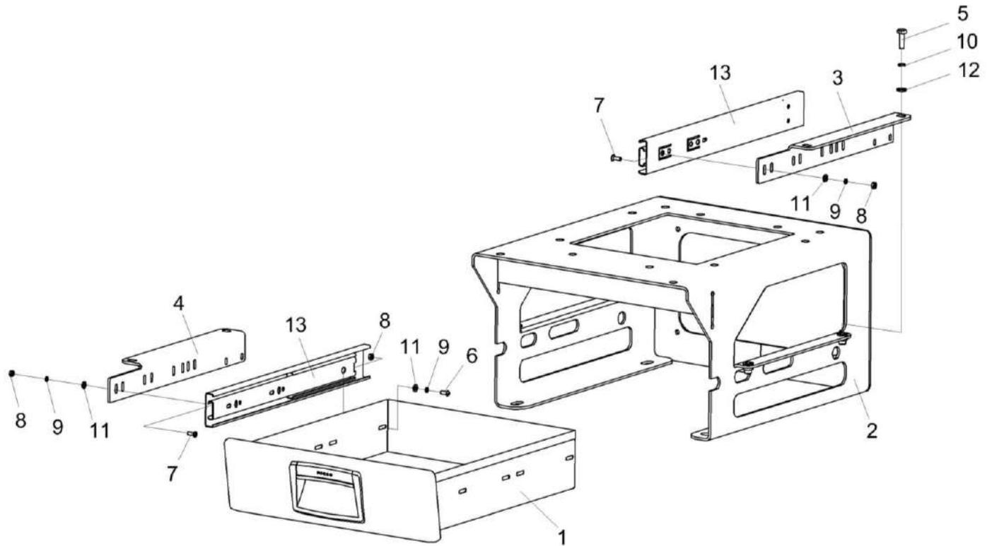
Рисунок 145 – Установка кронштейна УКЗ-01-0230010
