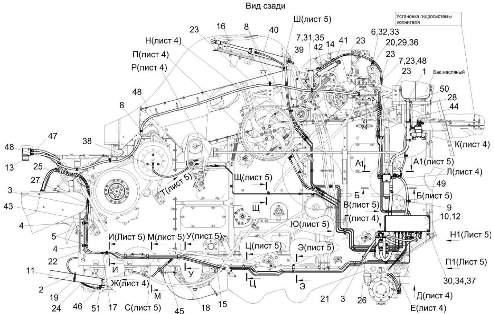
Рисунок 274 – Гидросистема рулевого управления и силовых гидроцилиндров КЗК-400-1-0602000 (лист 3)
