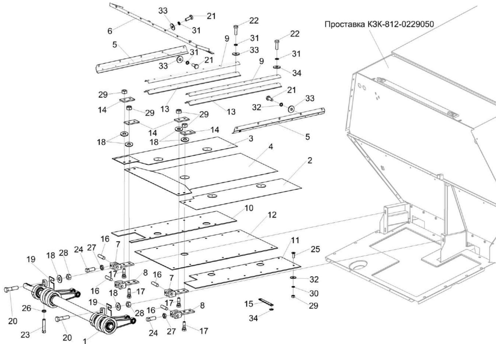
Рисунок 90 – Установка вибродна КЗК-7-0226000
