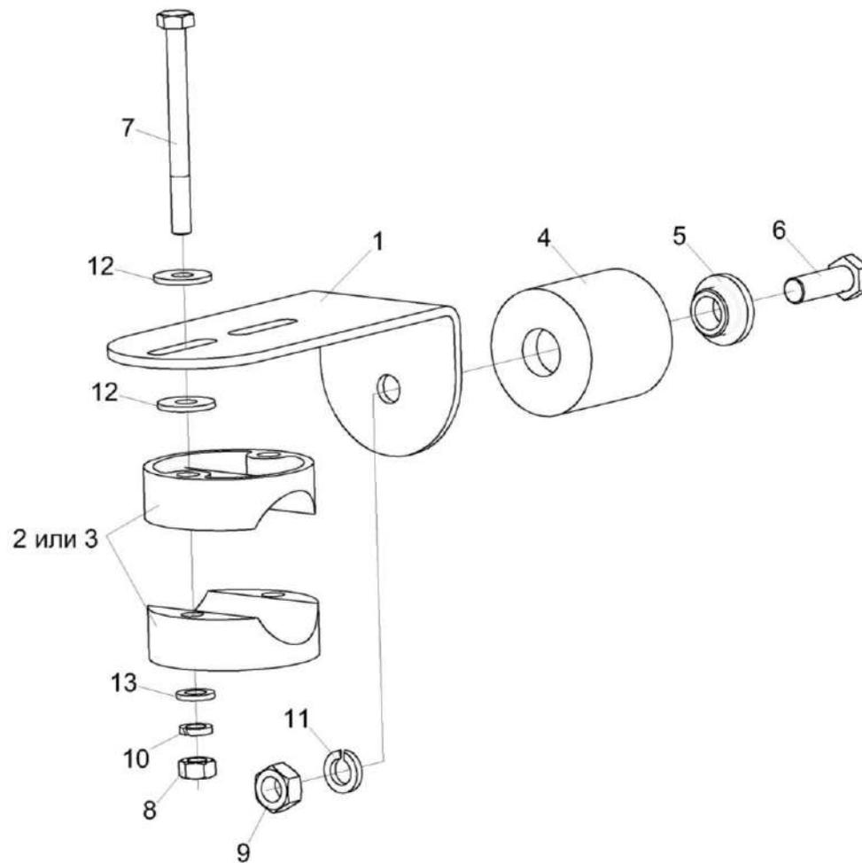
Рисунок 241 – Установка упора КЗК-8-9-0121050
