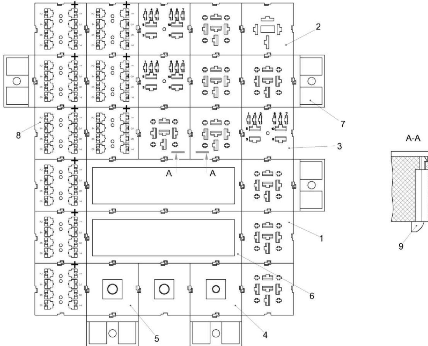
Рисунок 260 – Сборка колодок блока реле пульта КЗК-8-9-0700660
