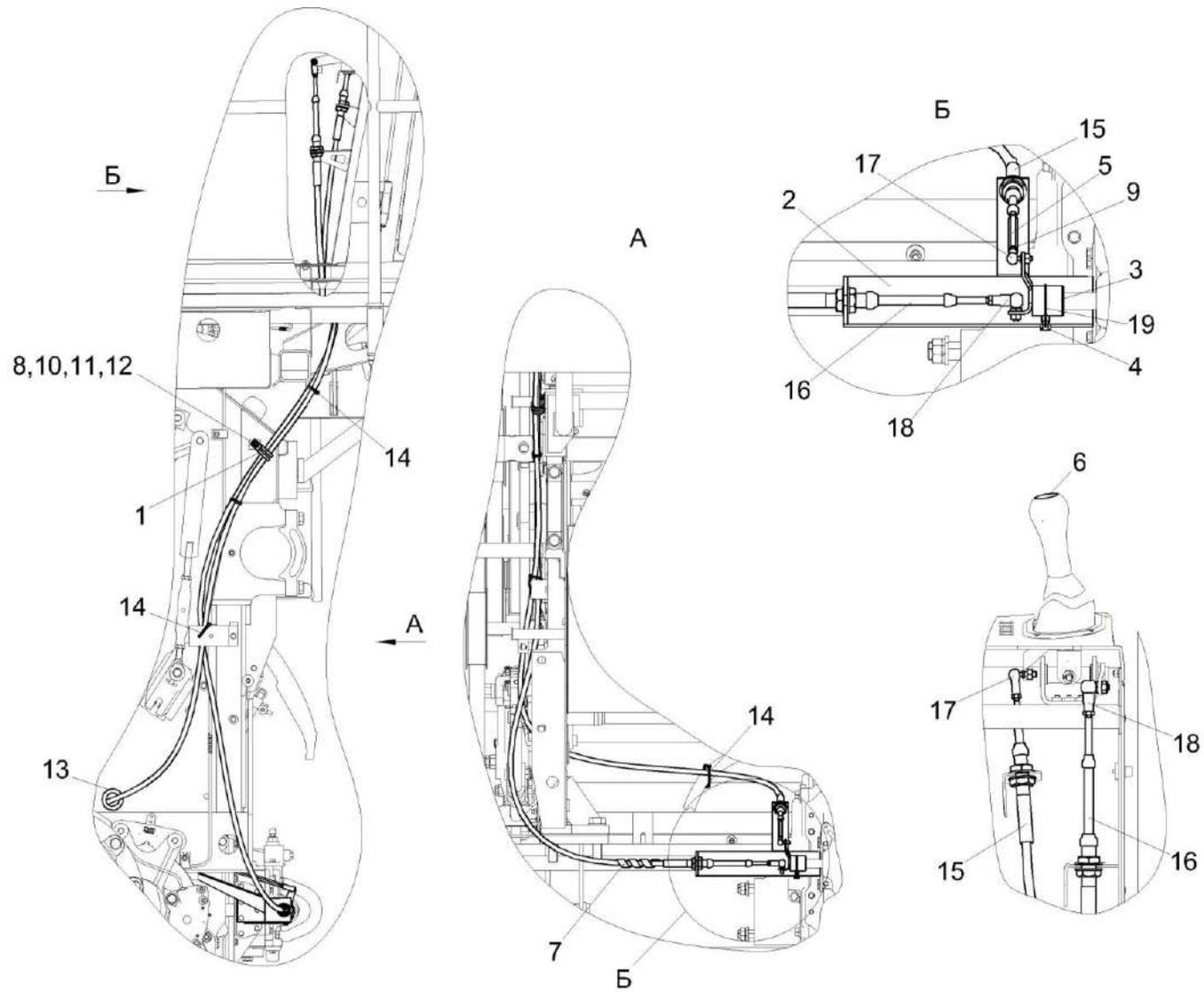
Рисунок 178 – Установка механизма переключения передач КЗК-8-8-0119650
