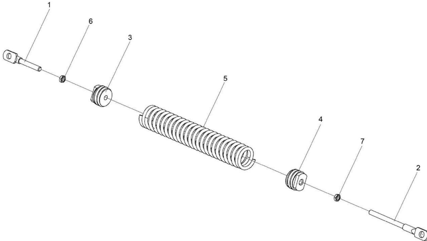
Рисунок 296 – Пружина КЗК 0125050
