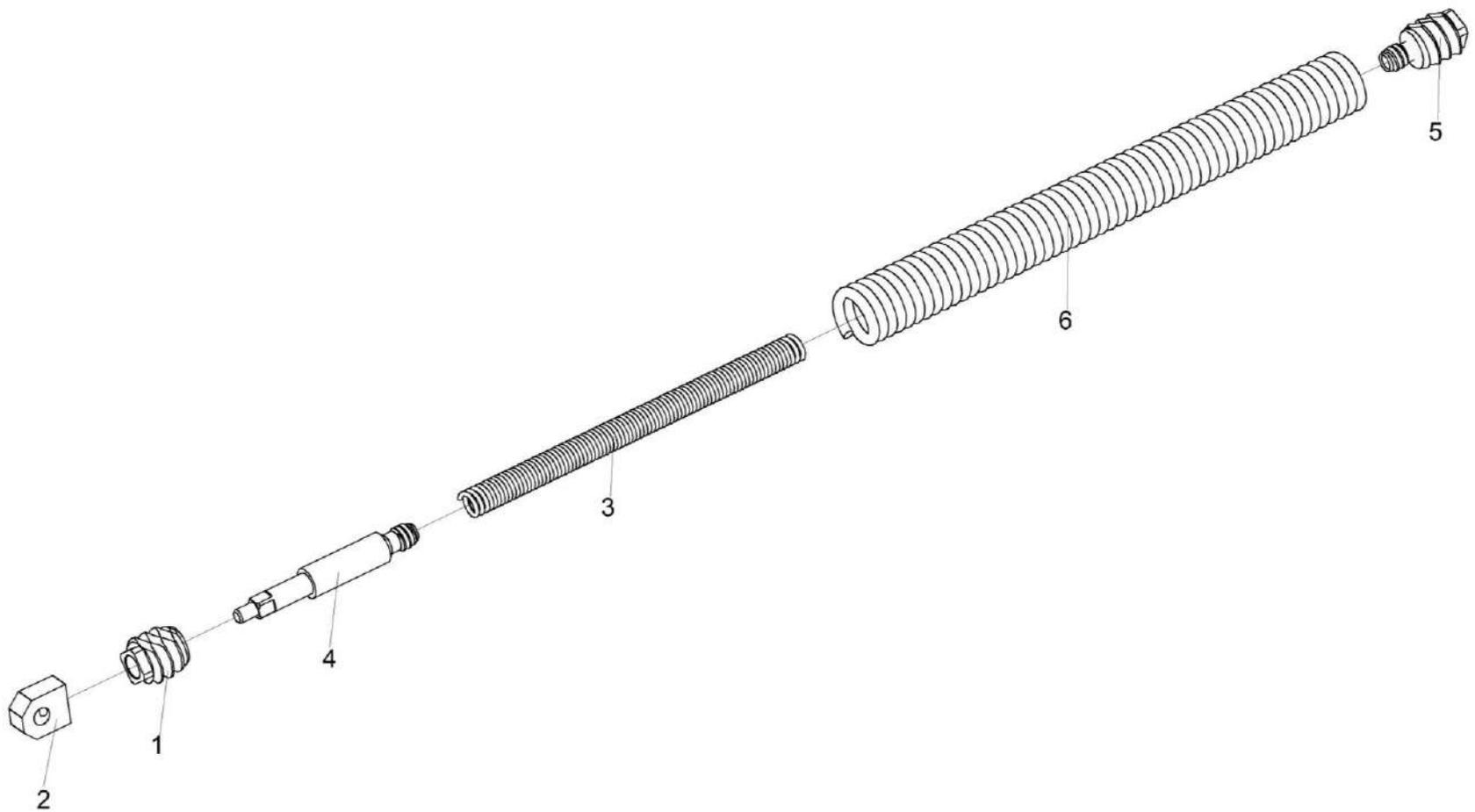
Рисунок 14 – Блок пружин КЗК 1775030
