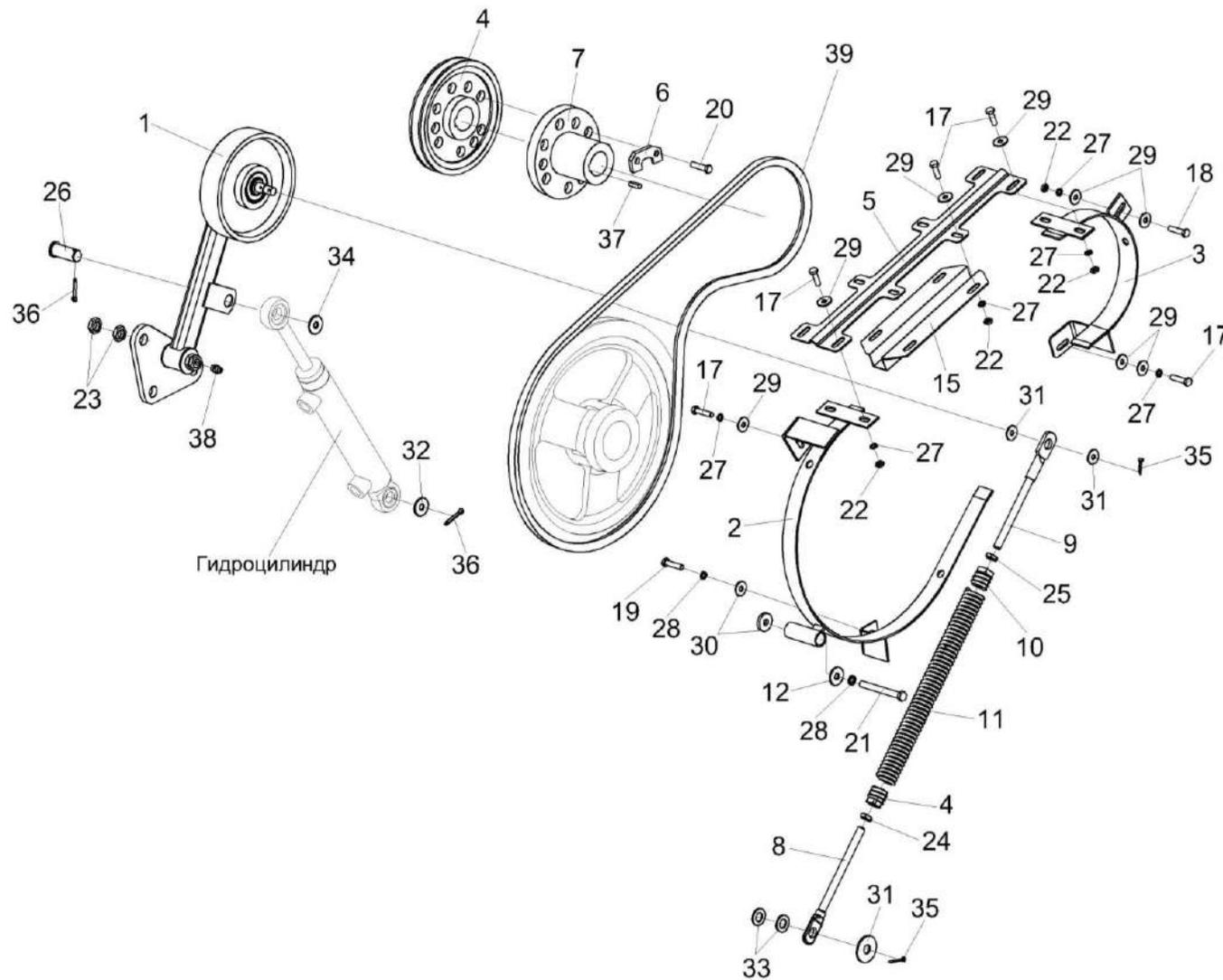
Рисунок 245 – Привод вибратора КЗК 0223000Б-01
