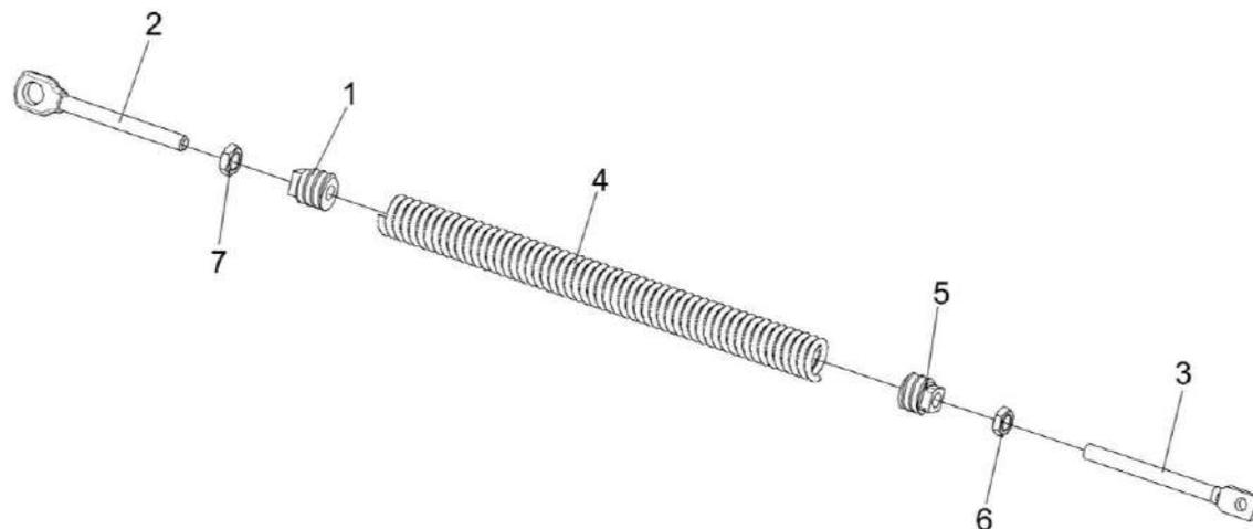
Рисунок 58 – Пружина КЗК 0202840А
