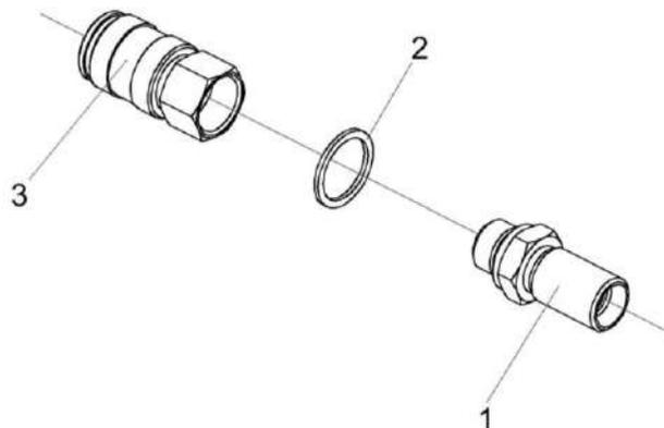
Рисунок 294 – Пневмовывод КНС-6028-0180110
