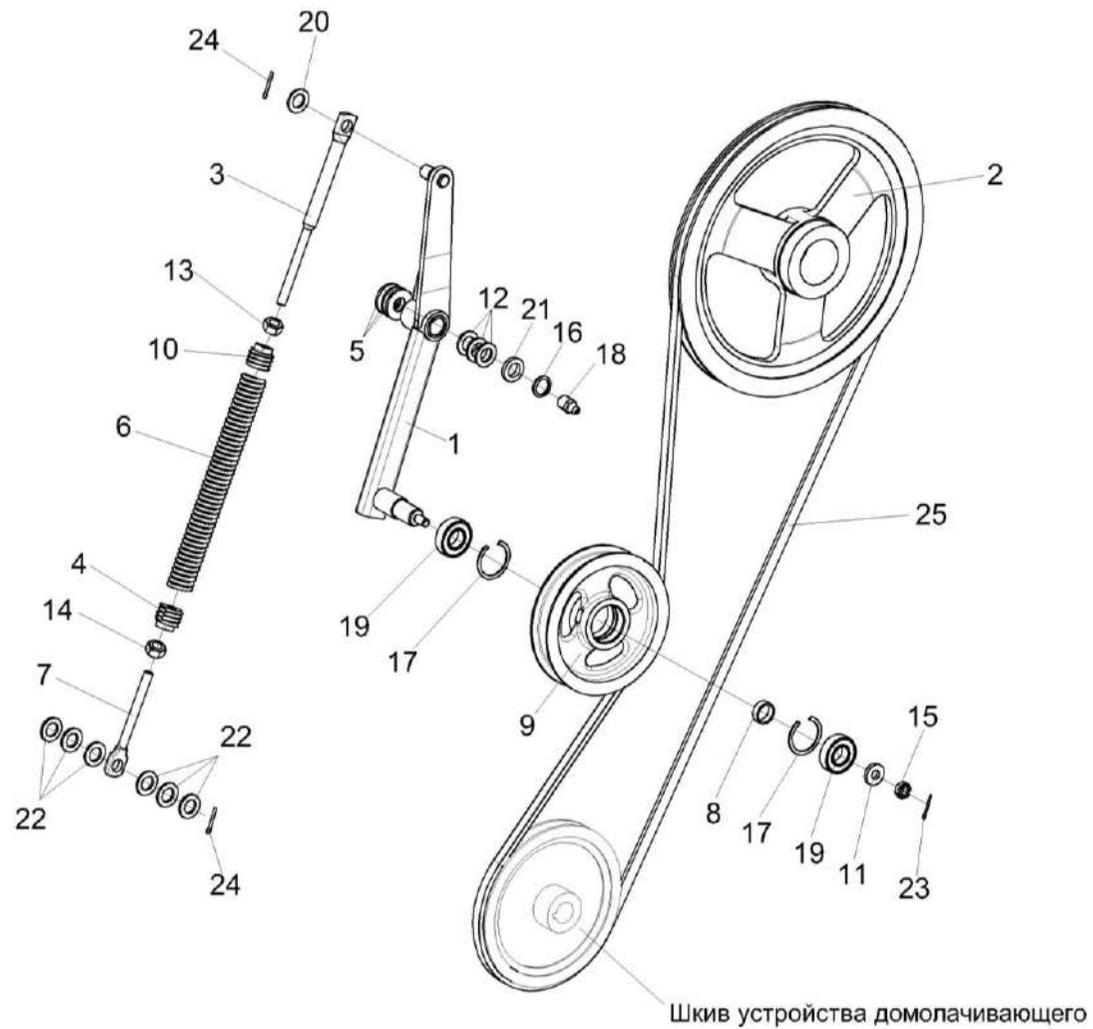
Рисунок 64 – Установка привода устройства домолачивающего
