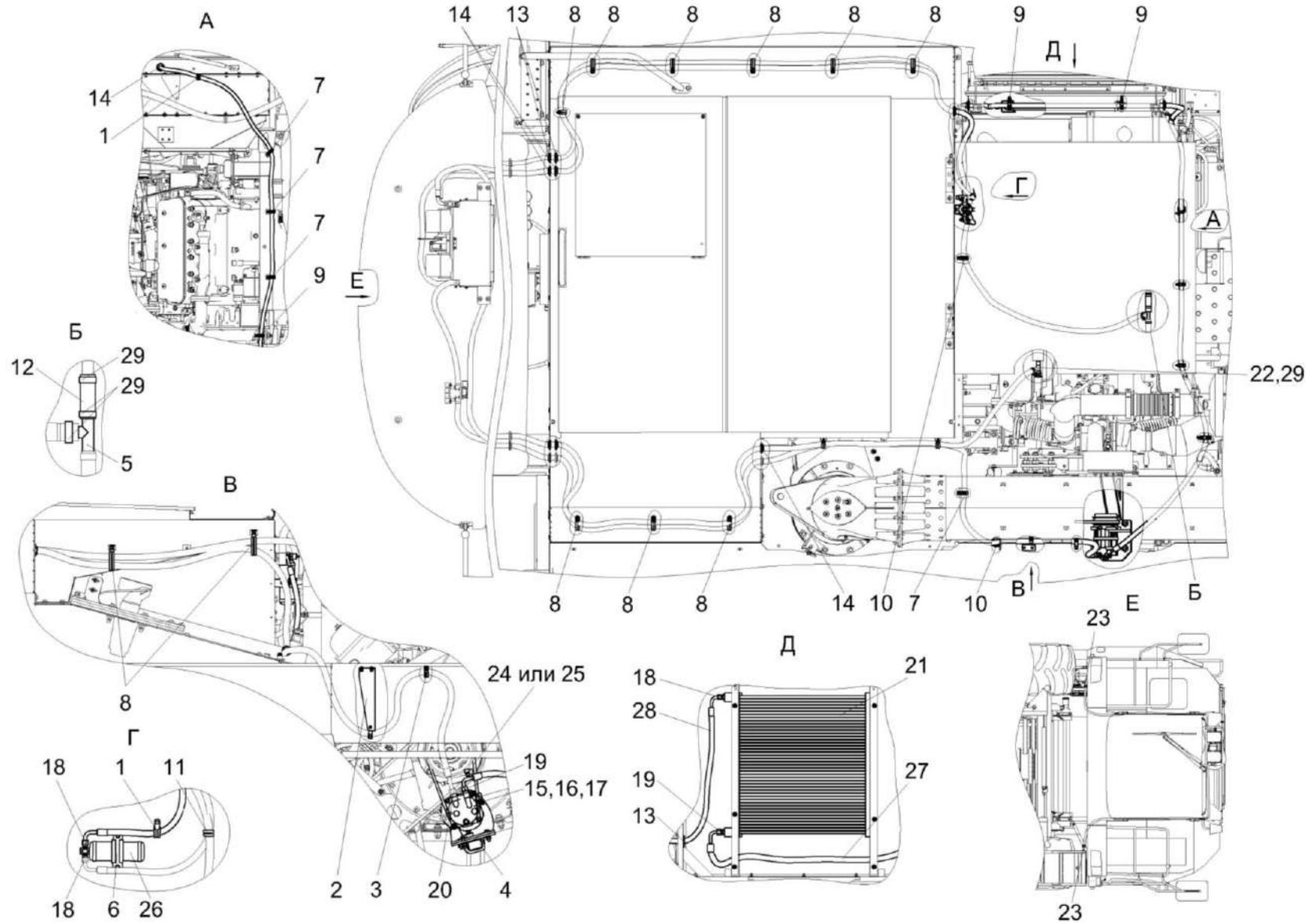
Рисунок 166 – Установка оборудования кондиционера КЗК-8-9-0113010
