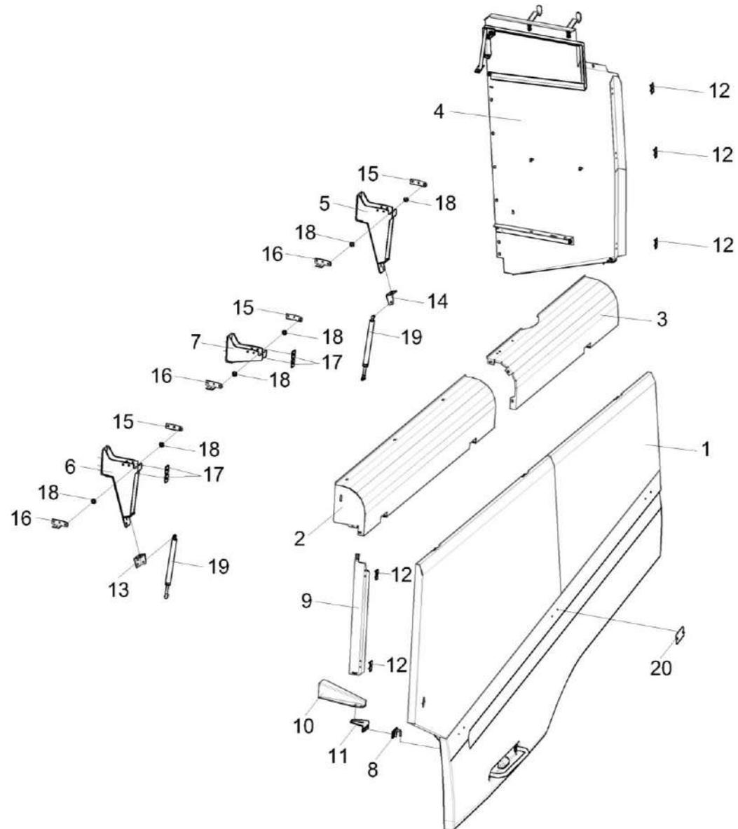
Рисунок 210 - Установка капотов и ограждений КЗК-400-1-0128000 (лист 1)
