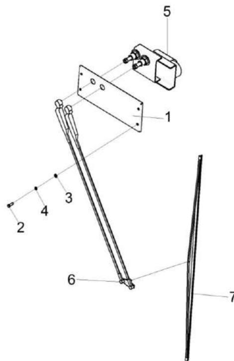
Рисунок 162 – Установка стеклоочистителя УКЗ-01-0101160
