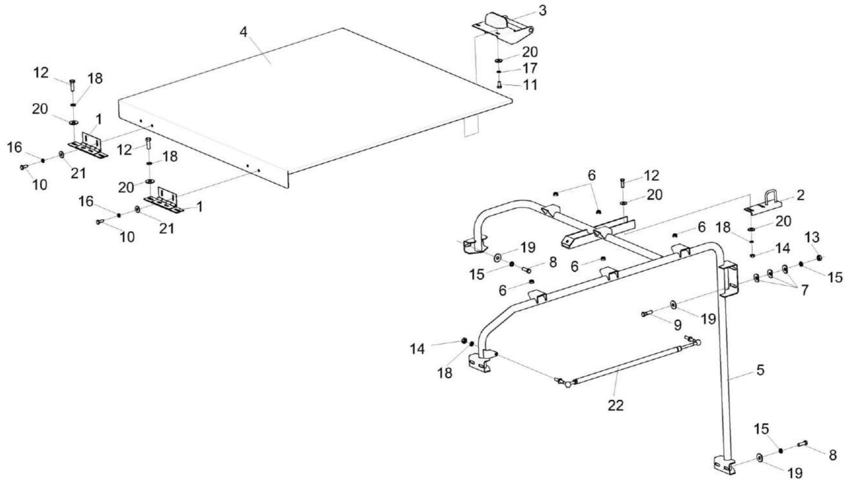
Рисунок 224 – Установка крыши моторного отсека КЗК-400-1-0124000
