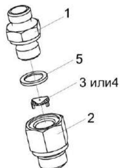
Рисунок 262 – Дроссель с обратным клапаном КЗК-1420-0609620, КЗК-1420-0609620-05, КЗК-1420-0609630-05
