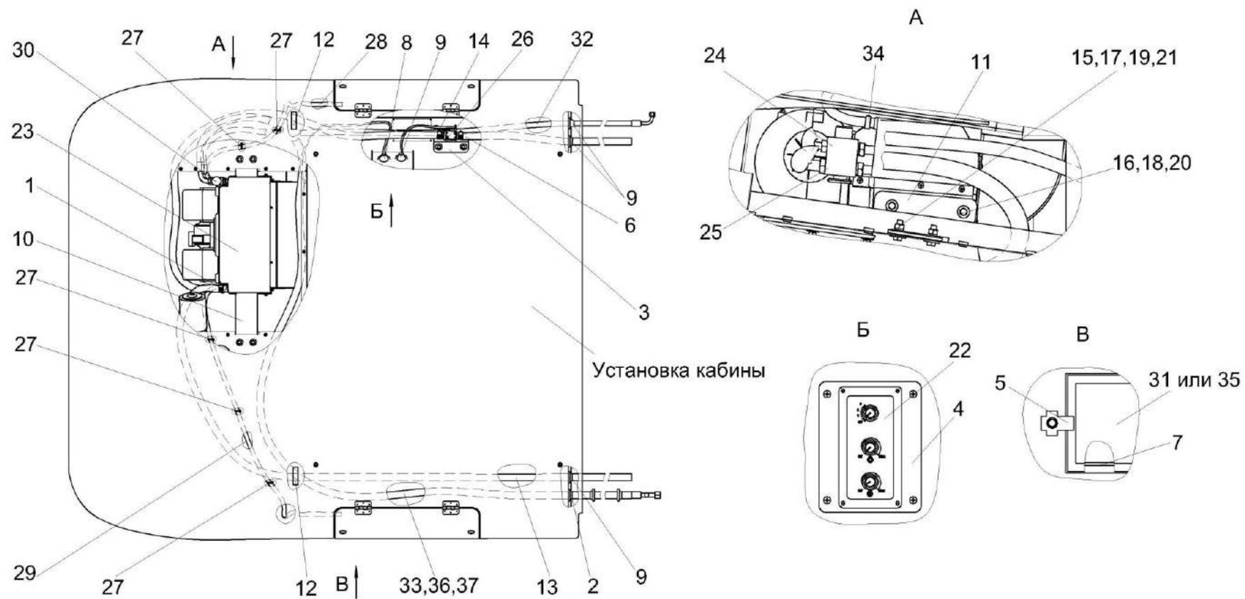
Рисунок 203 – Установка испарителя КЗК-8М-0113020
