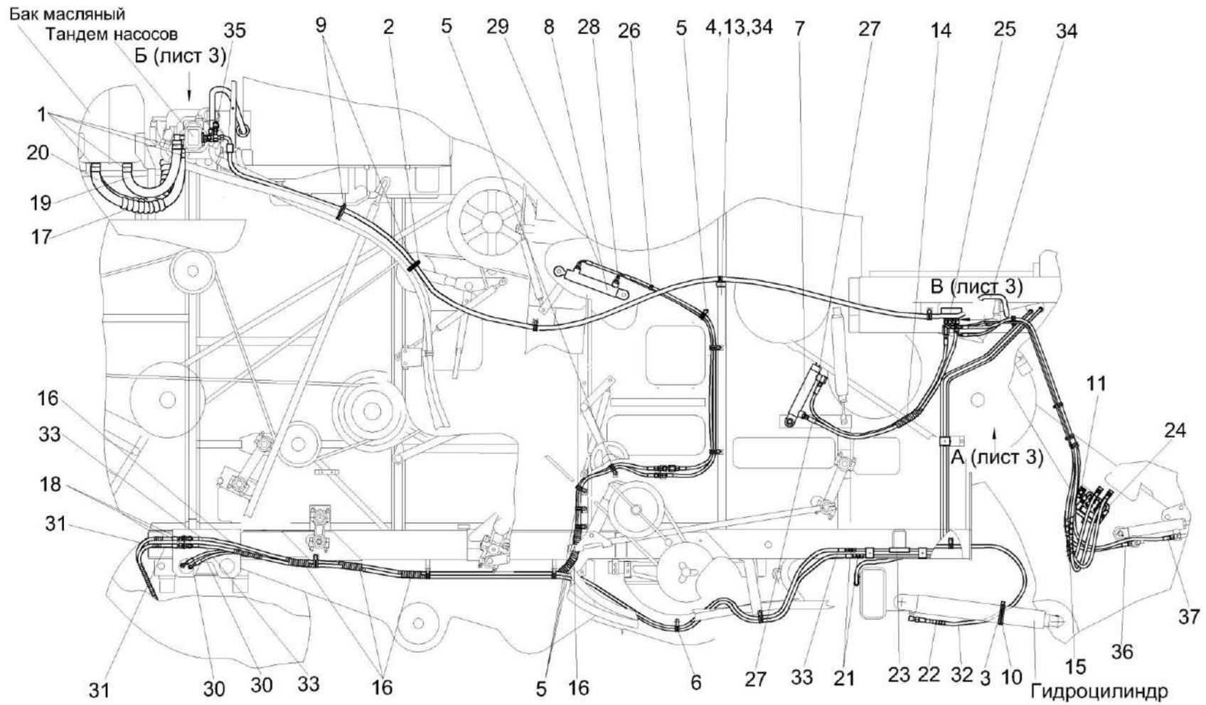
Рисунок 243 – Гидросистема рулевого управления и силовых гидроцилиндров КЗК-8А-2-0602000-03 (лист 1)
