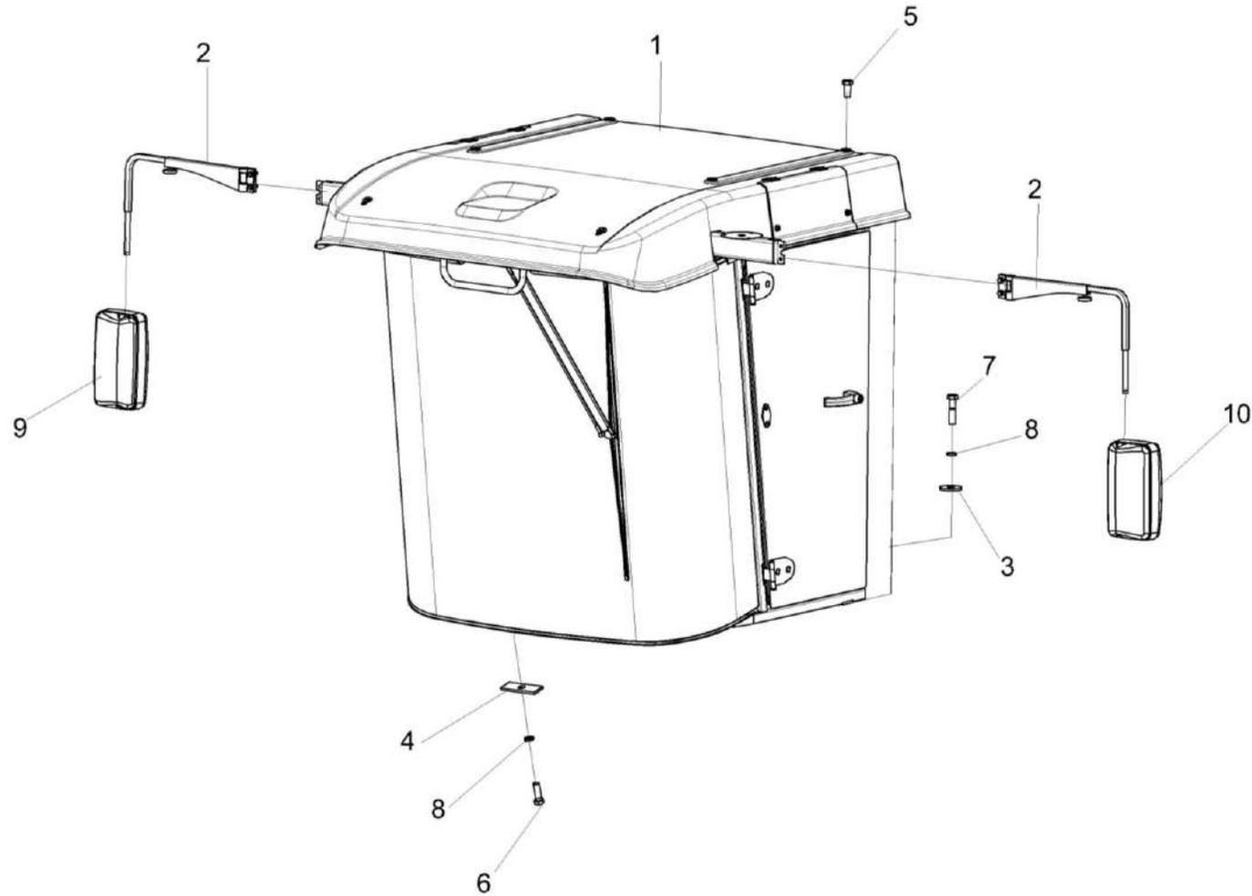
Рисунок 186 – Установка кабины КЗК-3219-0120000
