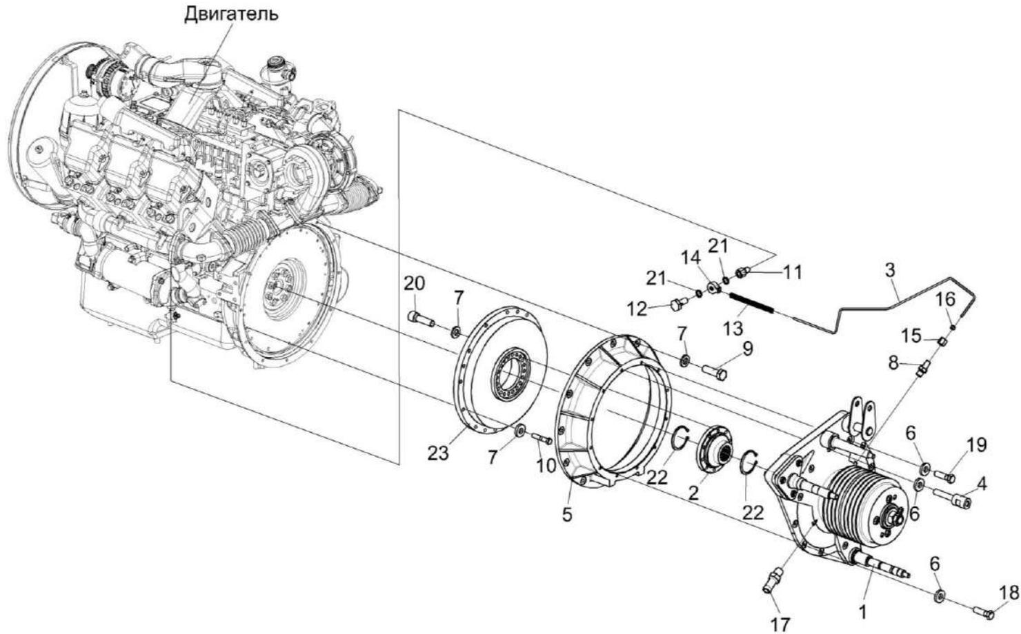
Рисунок 171 – Установка главного привода КЗК-8А-2-0106030
