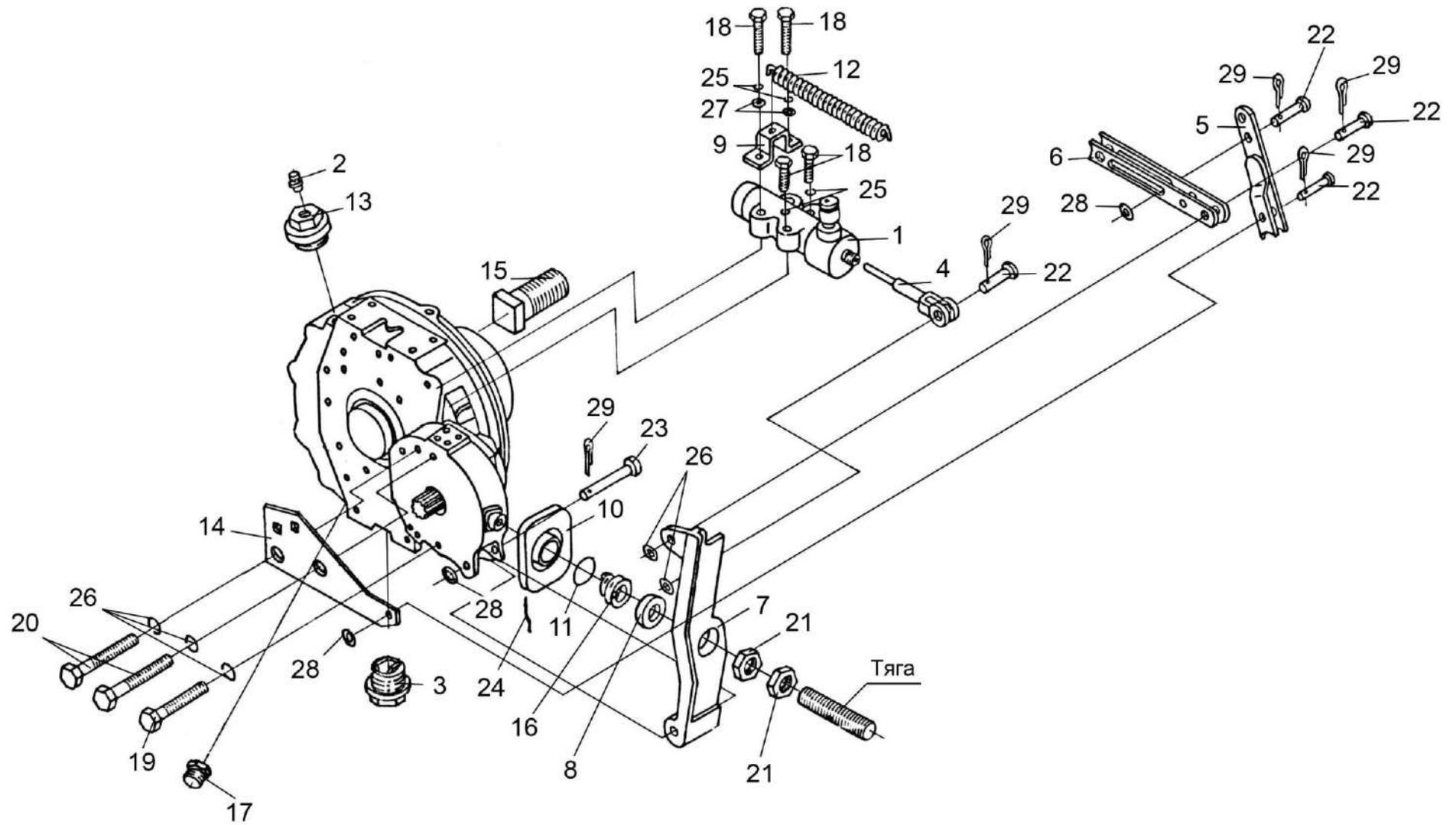
Рисунок 86 – Редуктор бортовой КЗК-10-0107200-01
