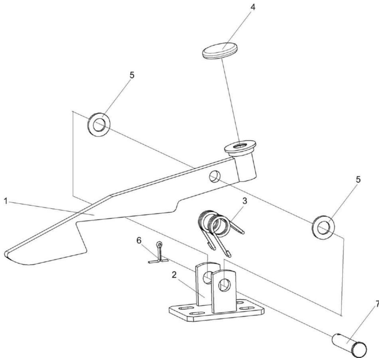
Рисунок 235 – Механизм фиксации трапа КЗС 0117100
