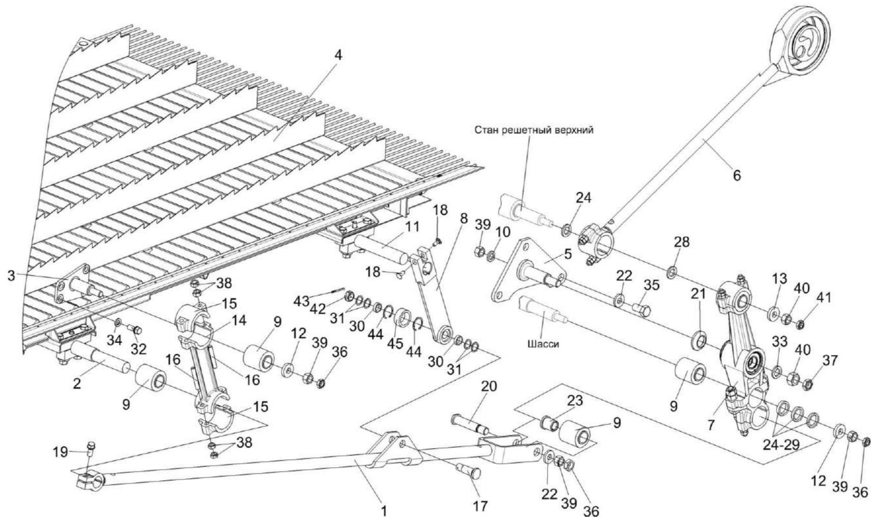
Рисунок 39 – Установка привода доски стрясной КЗК 0280000А (вид слева)
