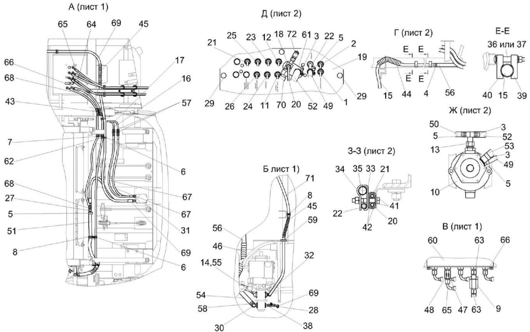
Рисунок 245 – Гидросистема рулевого управления и силовых гидроцилиндров КЗК-8А-2-0602000 (лист 3)
