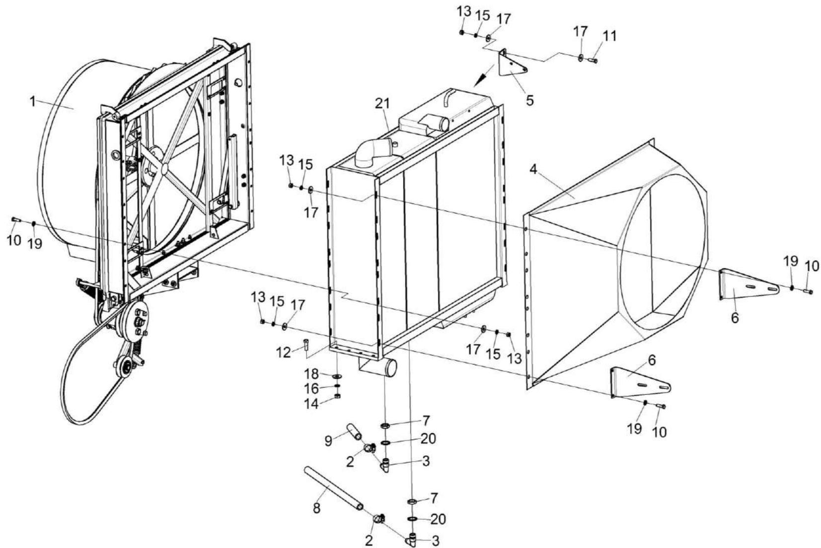
Рисунок 156 – Блок радиаторов КЗК-812С-3-0106040
