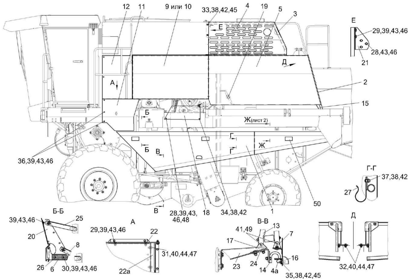
Рисунок 224 – Установка капотов и ограждений КЗК-8А-0128000-03 (лист 1)
