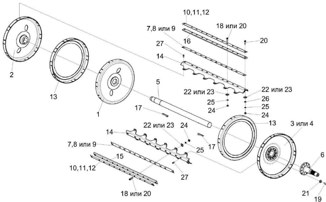
Рисунок 71 – Барабан молотильный КЗК-8А-0104000
