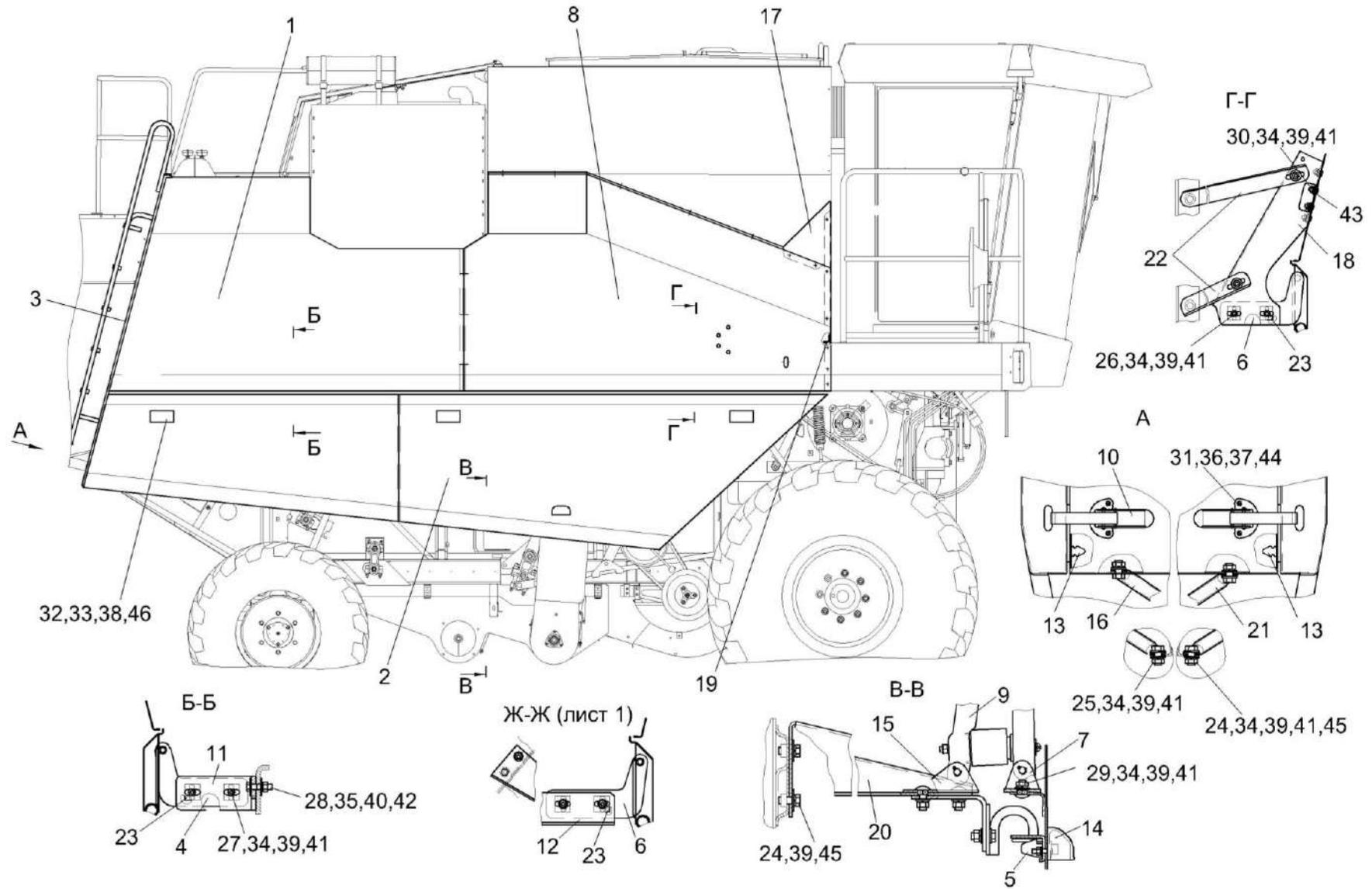
Рисунок 225 – Установка капотов и ограждений КЗК-8А-0128000-03 (лист 2)
