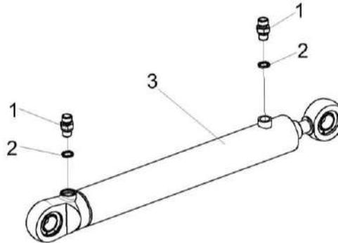
Рисунок 254 – Гидроцилиндр КЗК 0602510
