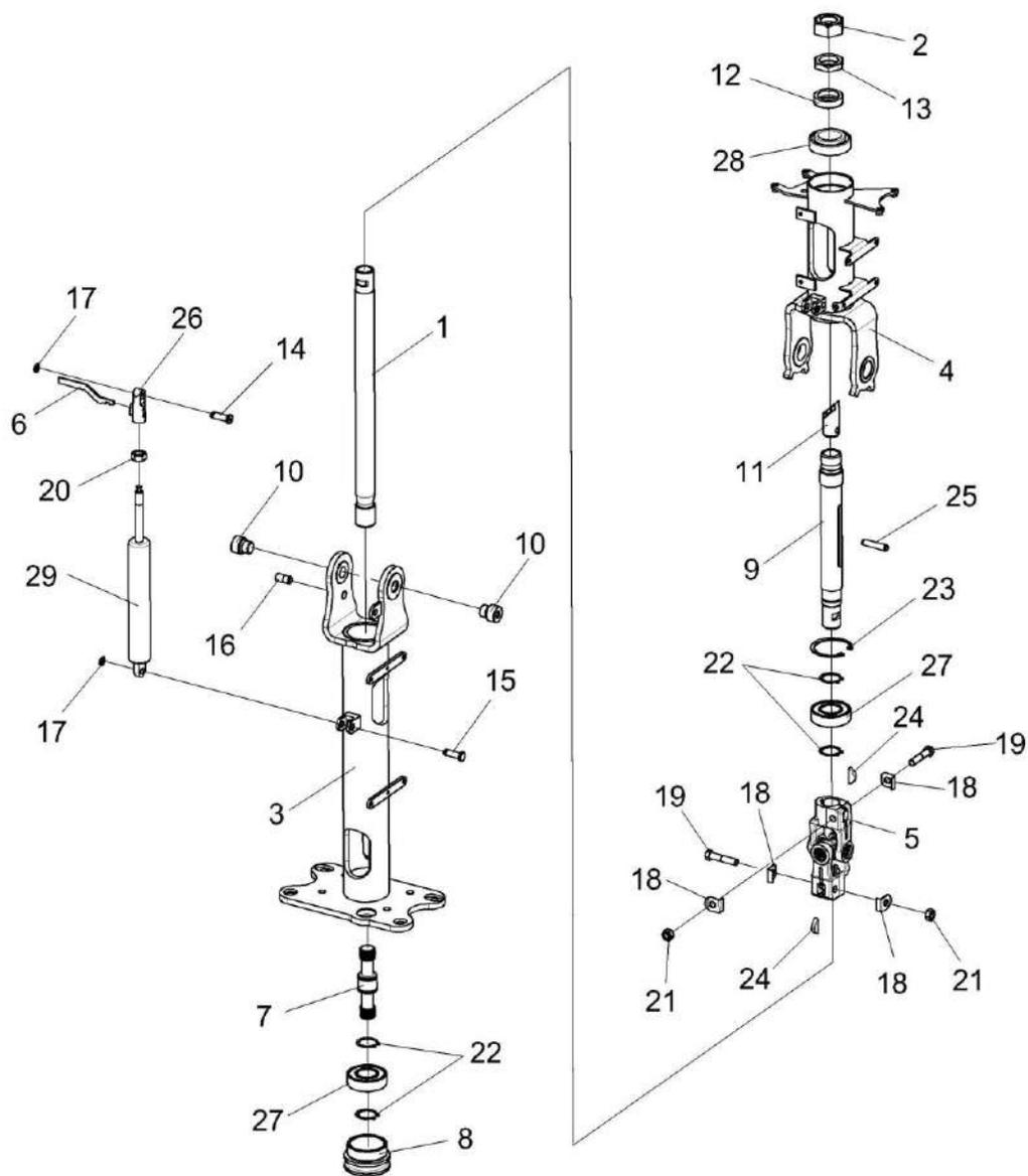
Рисунок 210 – Каркас КЗК-12-12-0119240
