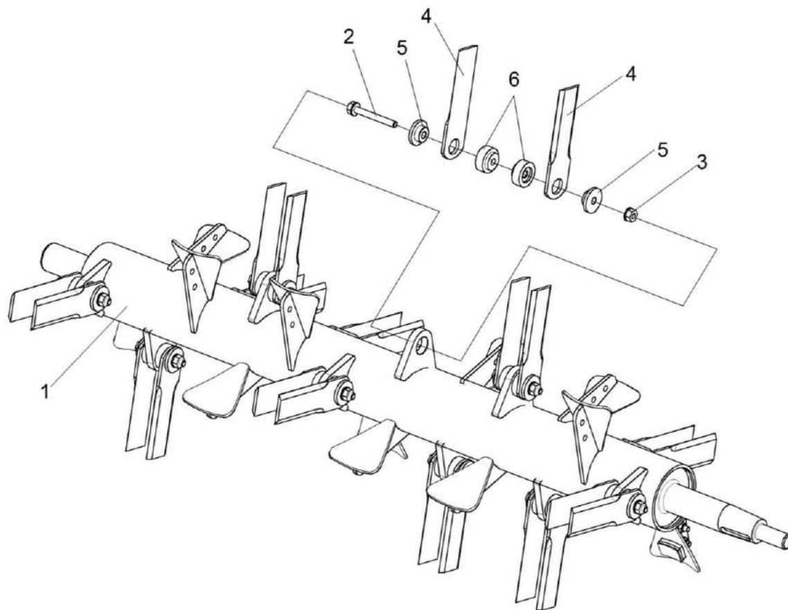
Рисунок 147 – Ротор измельчителя КЗК-8-0290140
