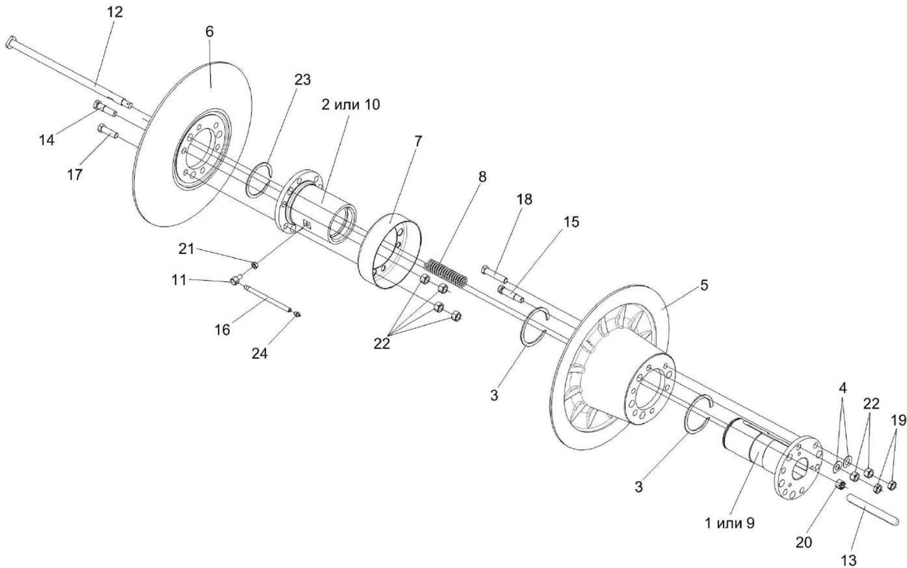
Рисунок 78 – Вариатор барабана КЗК 0108100-01
