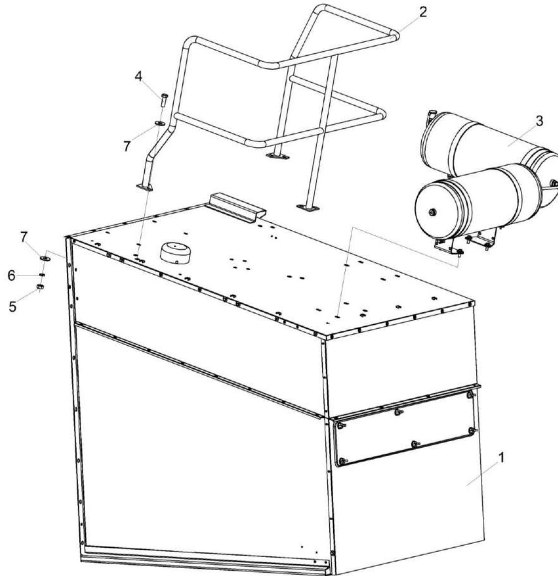
Рисунок 226 – Установка капота КЗК-8А-10-2-0228100
