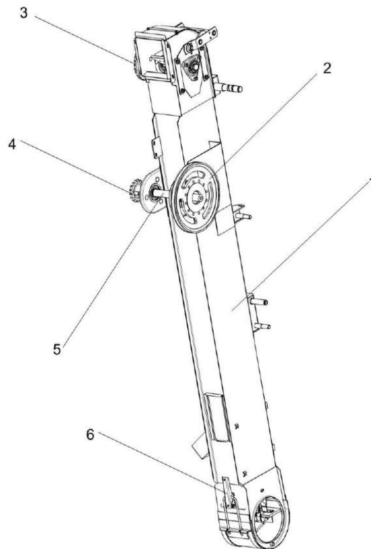
Рисунок 112 – Элеватор зерновой КЗК 0214000Б-02 (лист 1)
