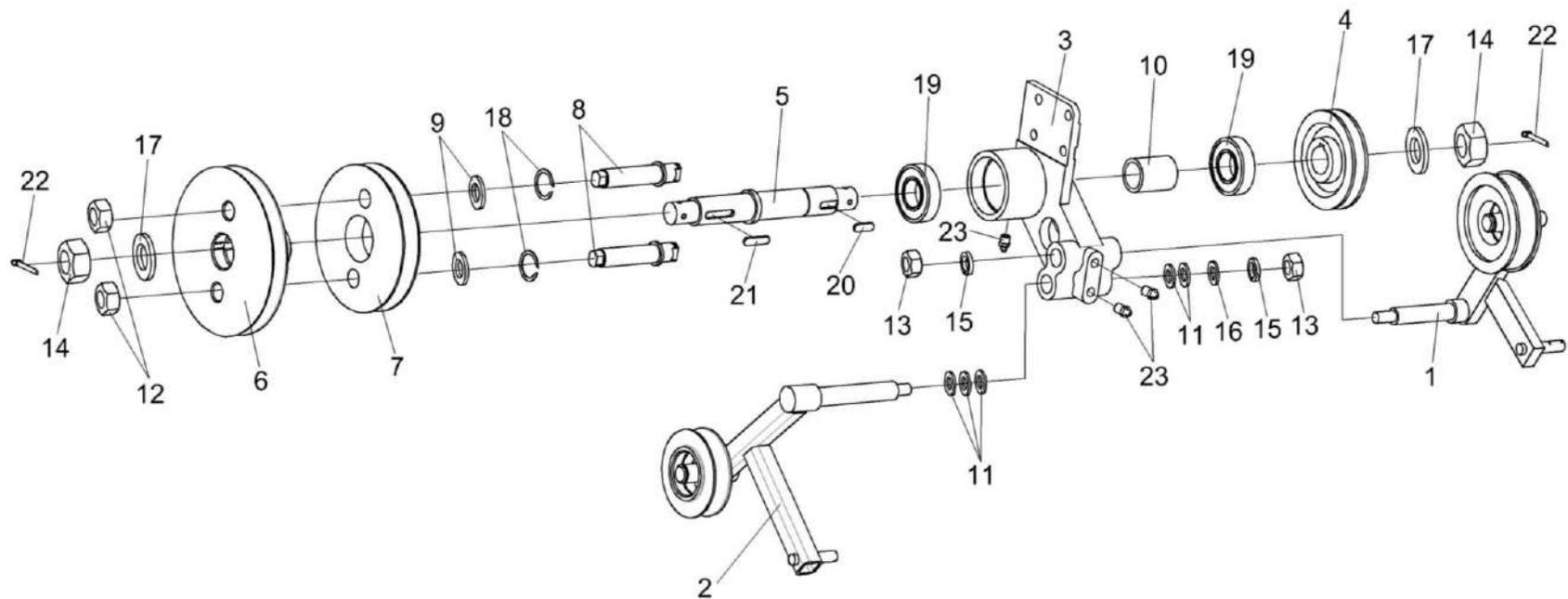
Рисунок 160 – Контрпривод КЗК 0112080А
