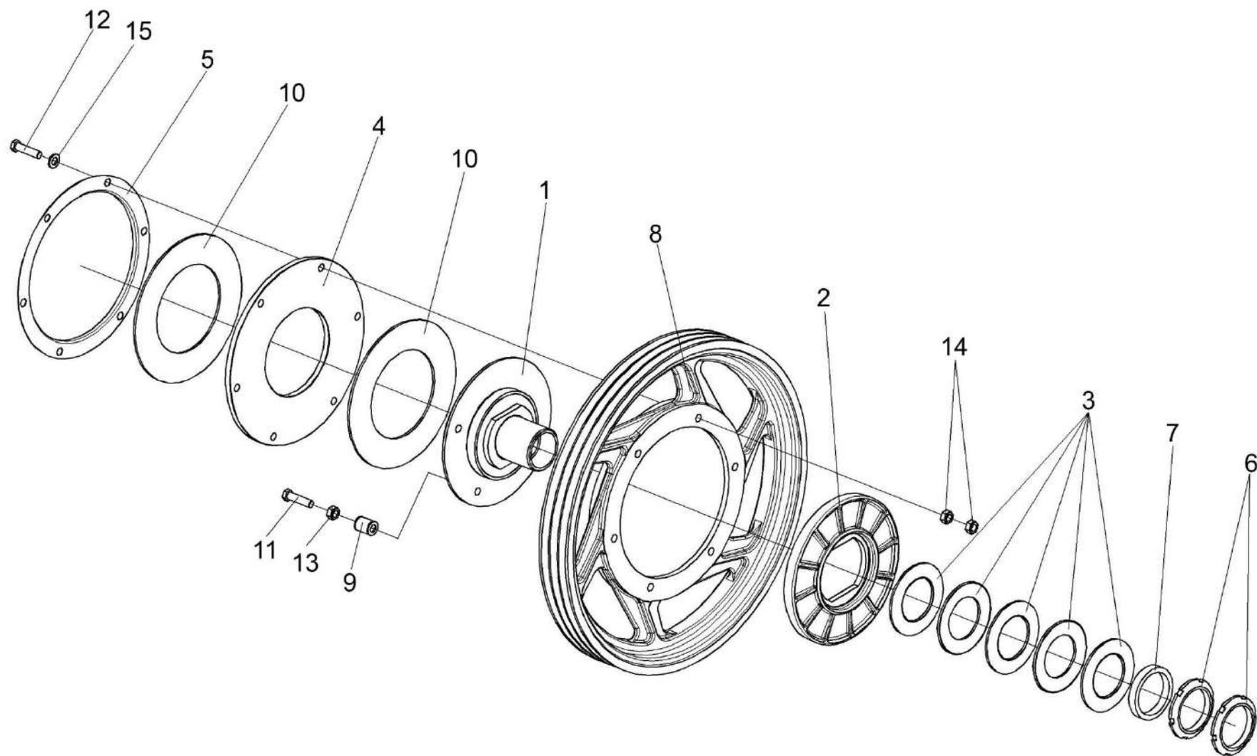
Рисунок 17 – Муфта предохранительная КЗК 1873100
