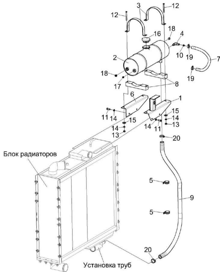
Рисунок 166 – Установка бачка расширительного КЗК-8К-0106070
