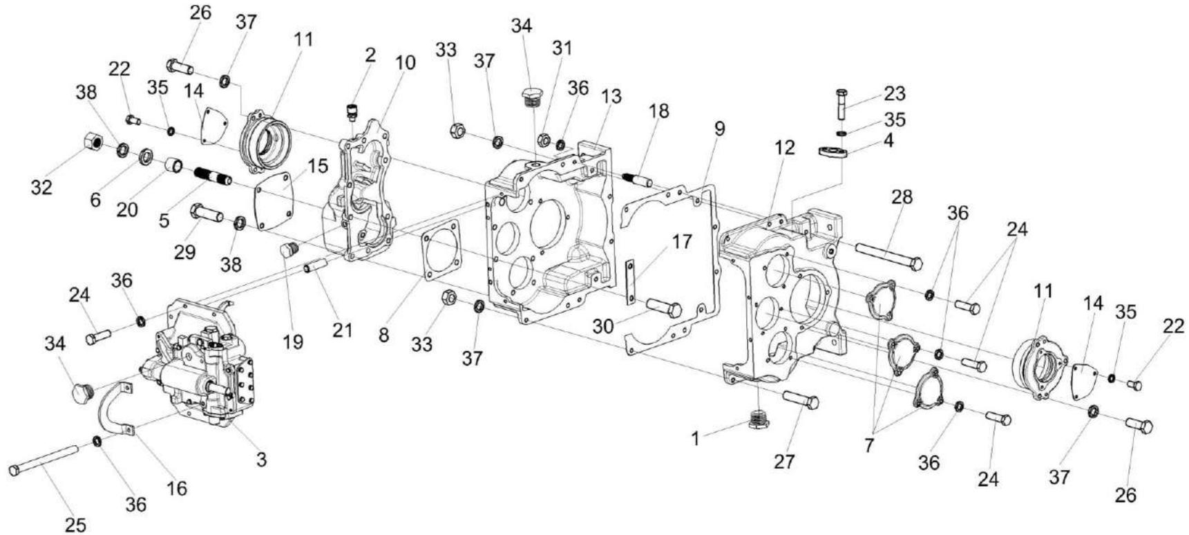
Рисунок 91 – Коробка передач КЗК-8-4-0107030 (корпус, крышки)
