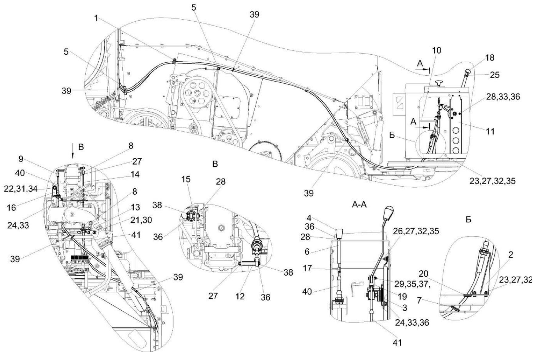
Рисунок 220 – Установка тросов управления двигателем КЗК-8М-0119640
