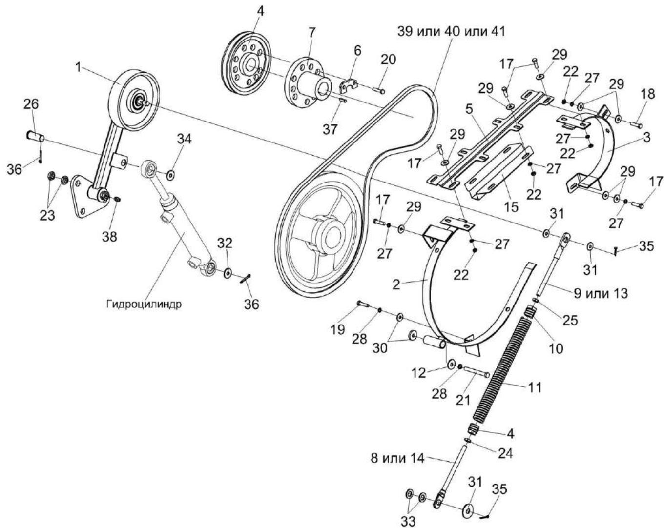
Рисунок 131 – Привод вибратора КЗК 0223000Б-01
