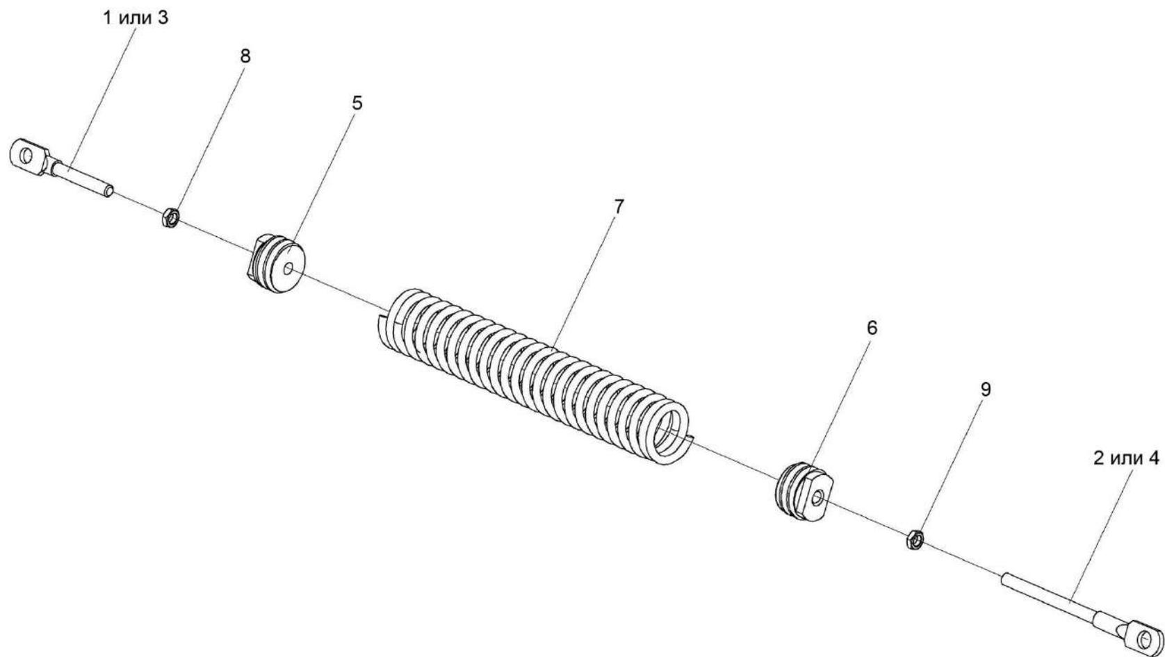
Рисунок 30 – Пружина КЗК 0125050
