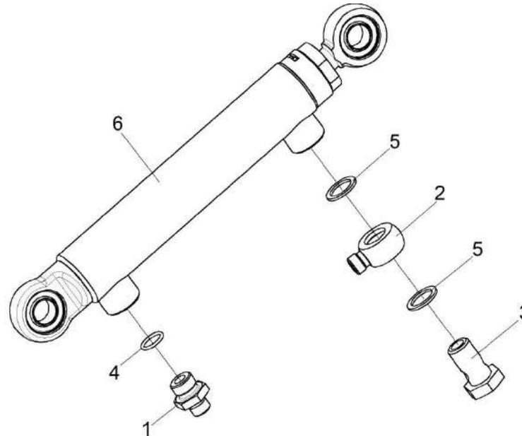
Рисунок 249 – Гидроцилиндр КЗК-8-0602500
