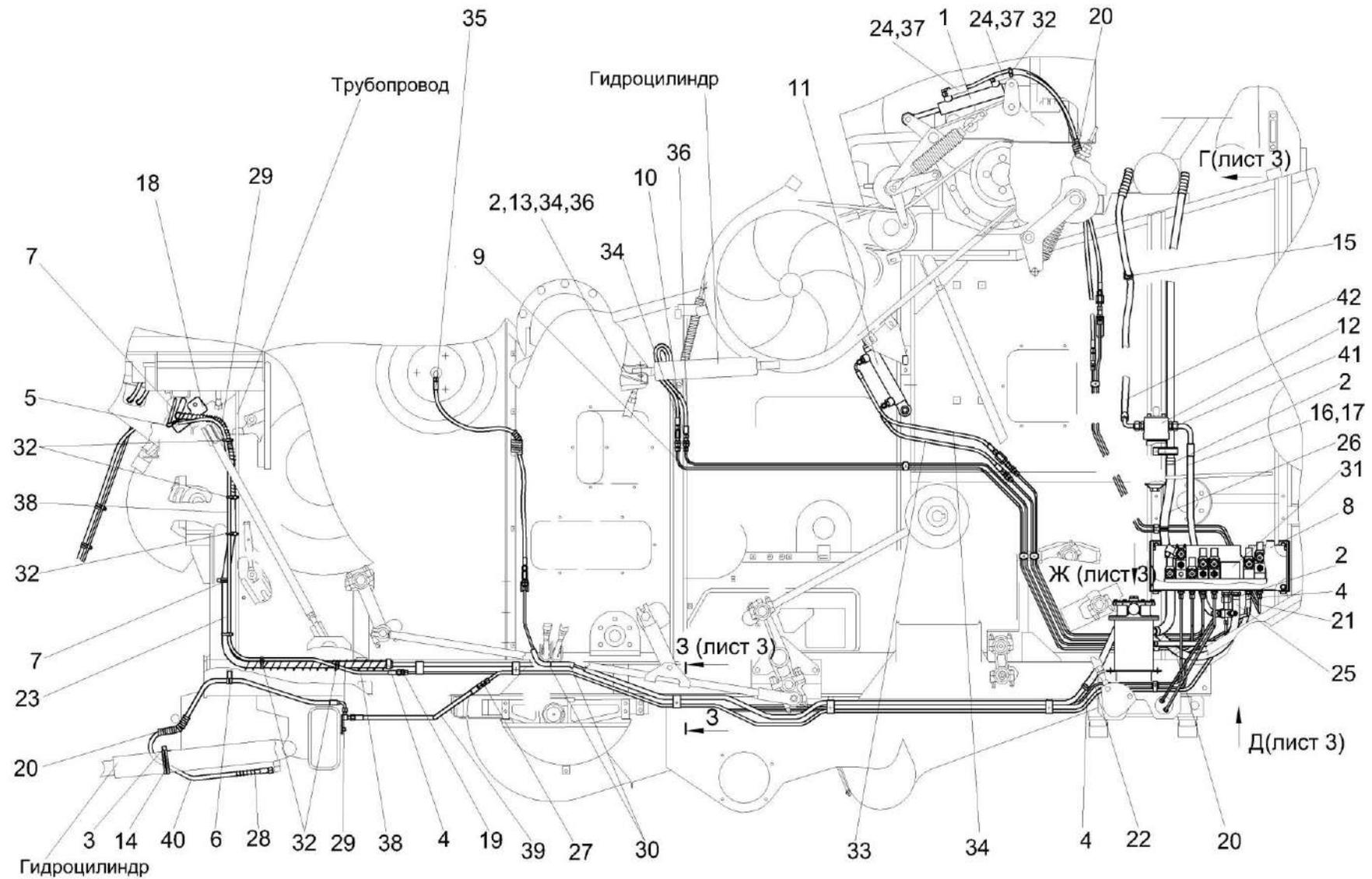
Рисунок 244 – Гидросистема рулевого управления и силовых гидроцилиндров КЗК-8А-2-0602000-03 (лист 2)
