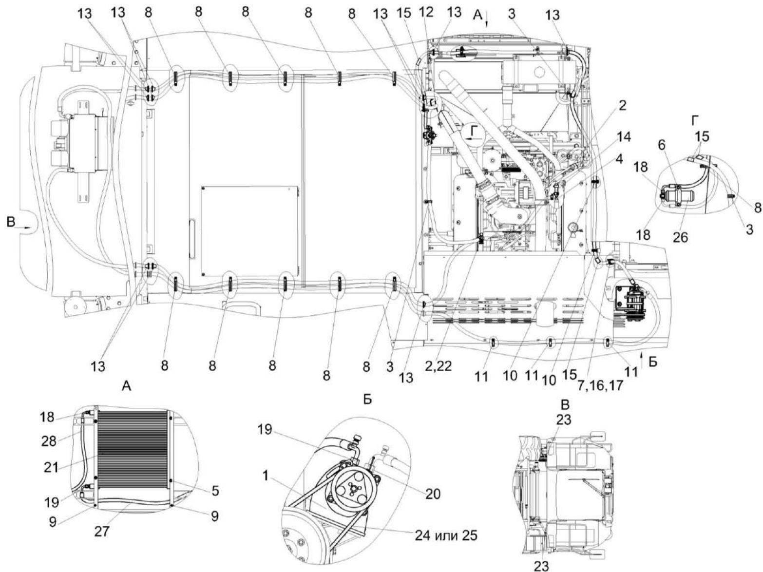
Рисунок 200 – Установка оборудования кондиционера КЗК-8М-0113010
