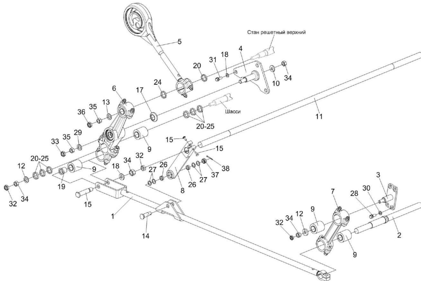
Рисунок 40 – Установка привода доски стрясной КЗК 0280000А (вид справа)
