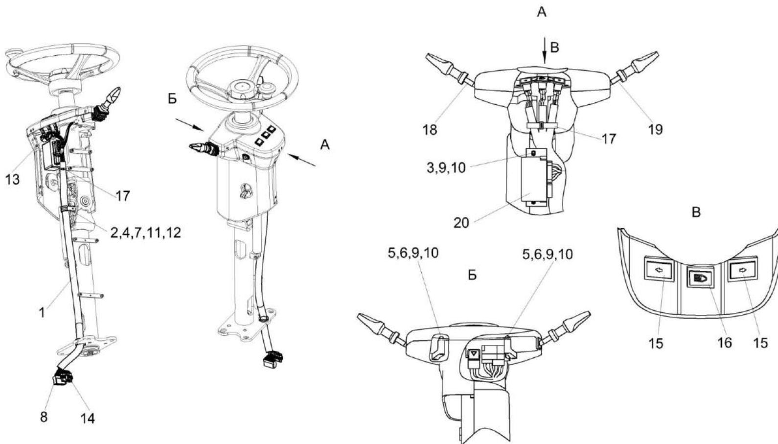
Рисунок 12 – Установка электрооборудования рулевой колонки КЗК-3219-0723000
