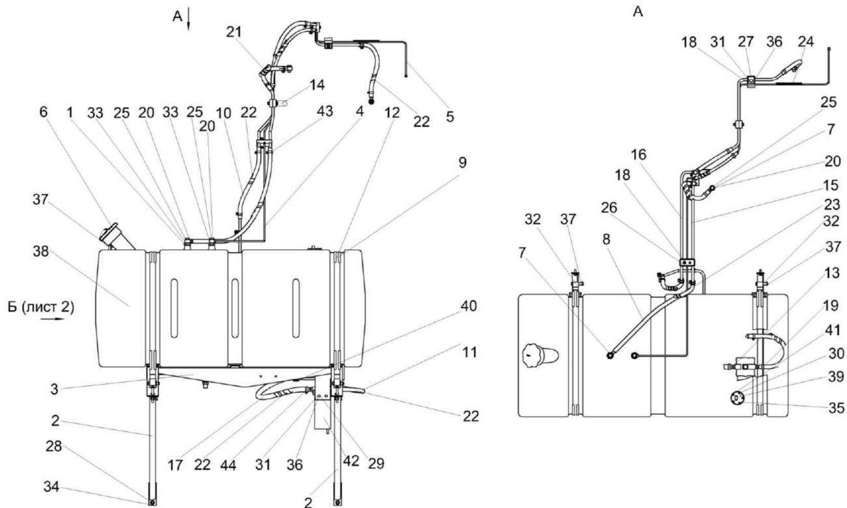
Рисунок 184 – Установка топливного оборудования КЗК-8К-0126000 (лист 1)
