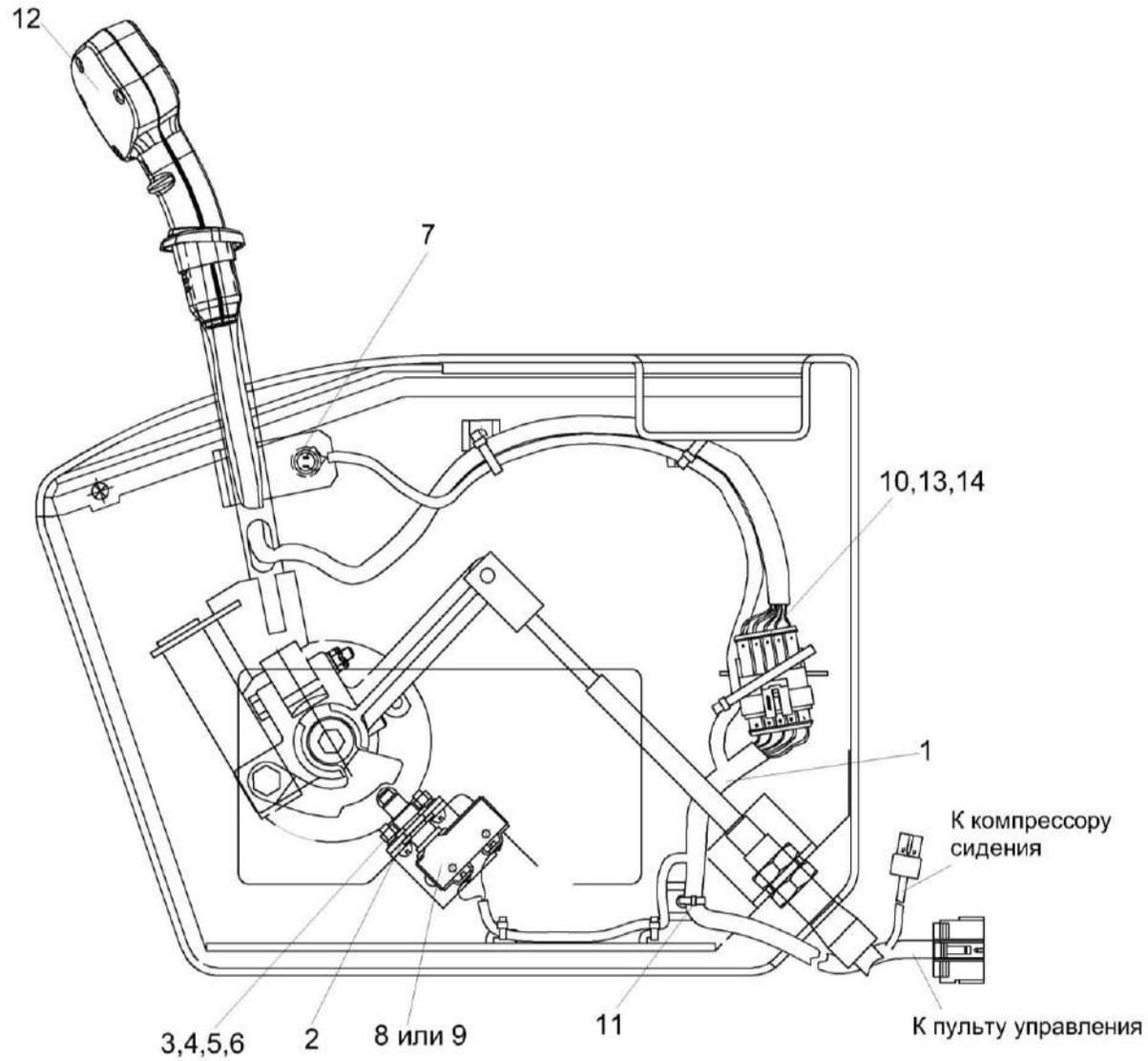
Рисунок 11 – Установка электрооборудования блока управления КЗК-12ПРО-0724000
