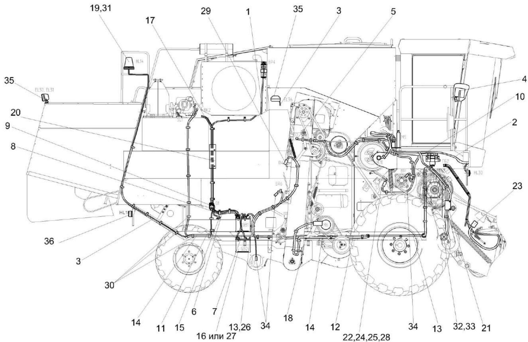
Рисунок 6 – Установка электрооборудования молотилки КЗК-8М-0721000 (вид справа)
