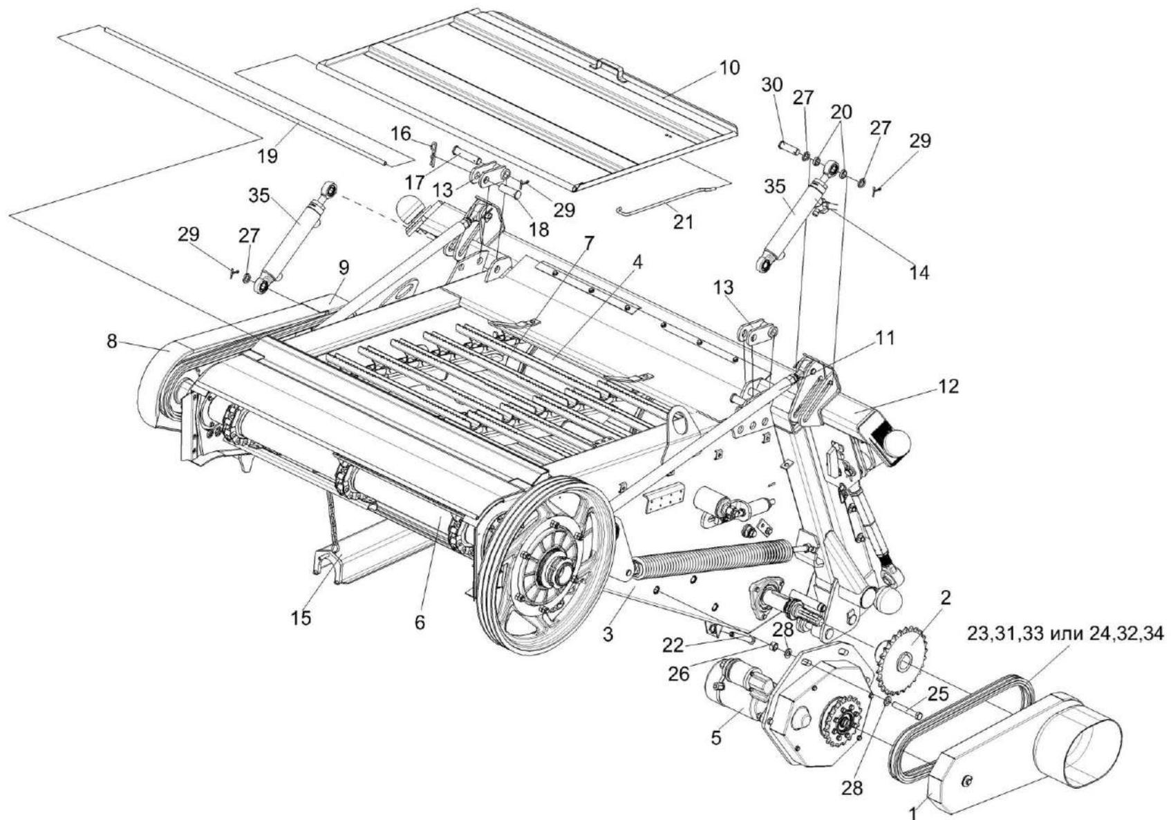
Рисунок 13 – Камера наклонная КЗК-8-1810000А
