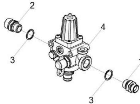
Рисунок 257 – Регулятор давления КЗК-10-0800190
