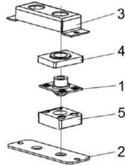
Рисунок 174 – Амортизатор КЗК-10-0106160
