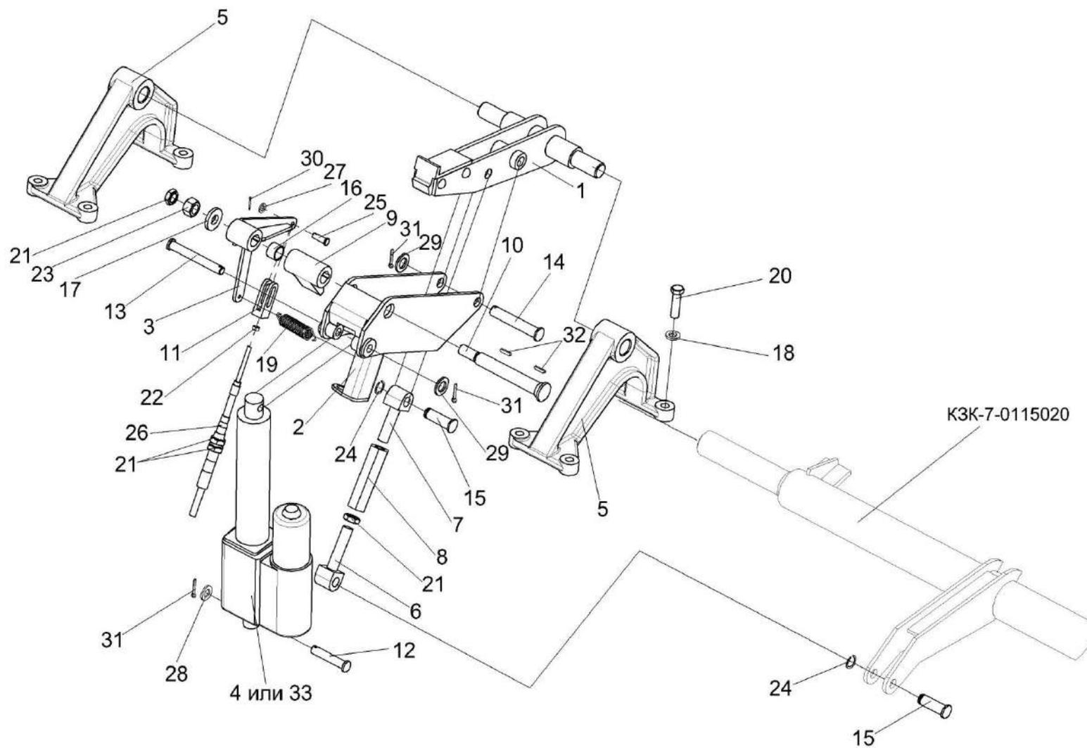
Рисунок 73 – Механизм подъема подбарабанья КЗК-8А-0115000 (установка электромеханизма)
