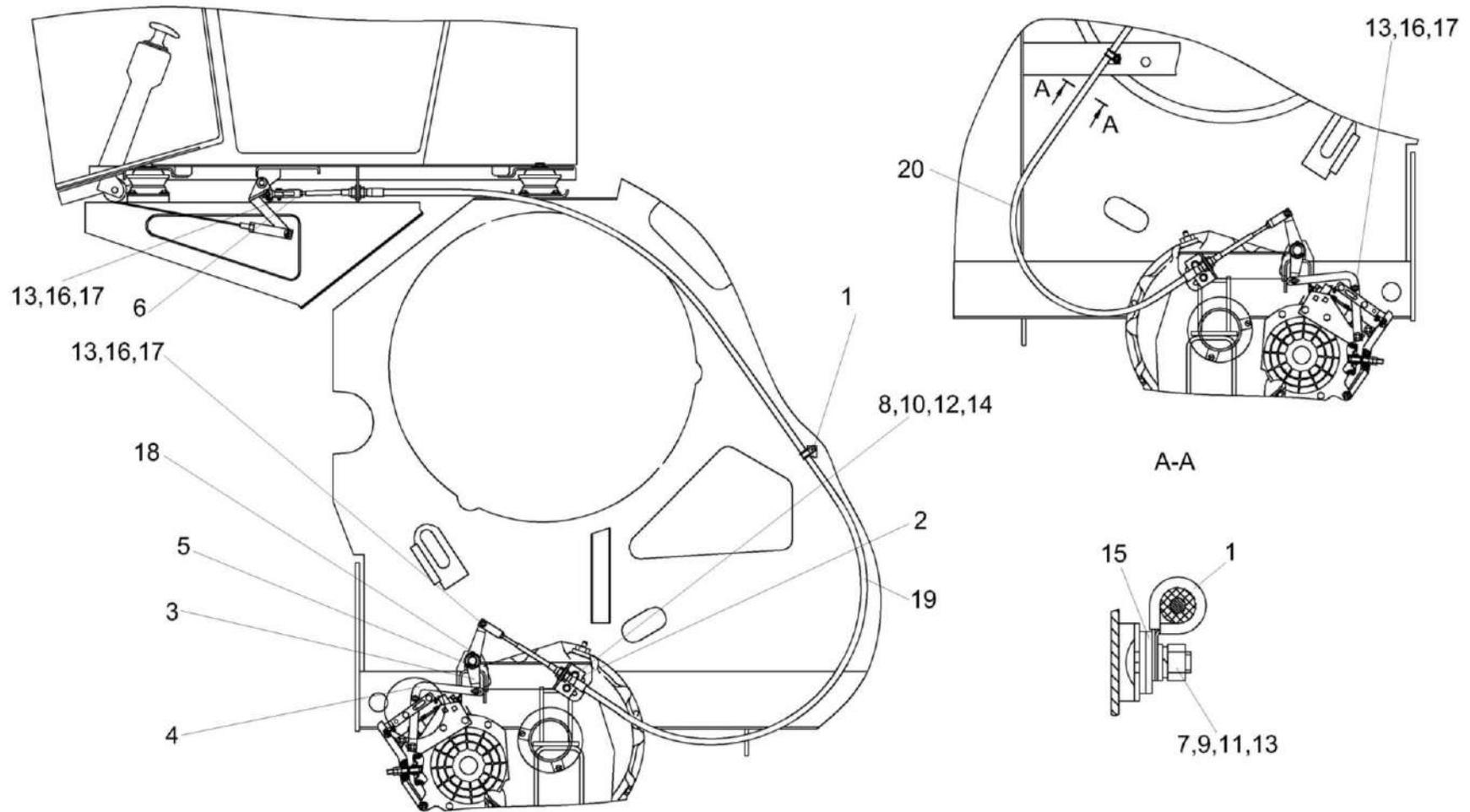
Рисунок 219 – Установка тросов управления стояночным тормозом КЗК-8М-0119610
