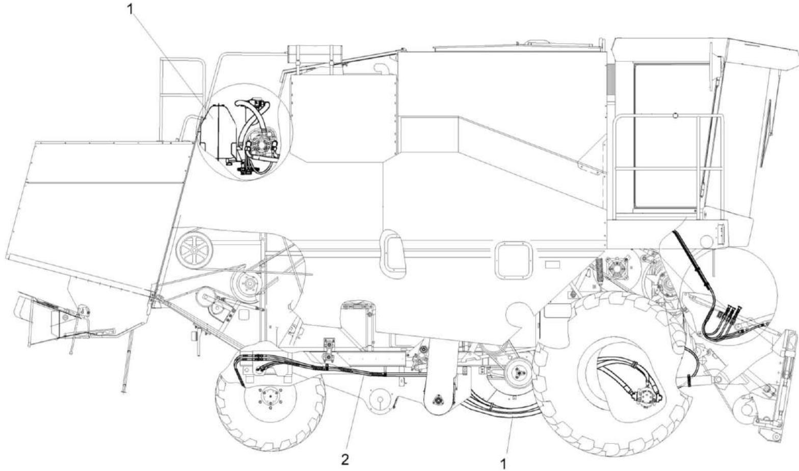
Рисунок 236 – Гидросистема КЗК-8М-0600000
