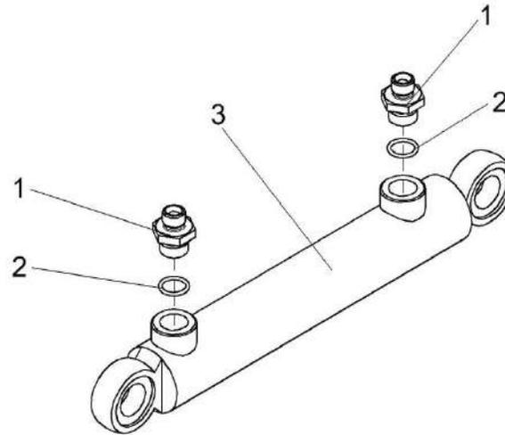
Рисунок 250 – Гидроцилиндр КЗК-12-0602310
