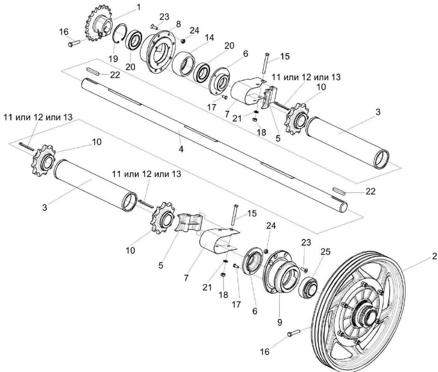
Рисунок 16 – Установка вала верхнего КЗК-8-1813000
