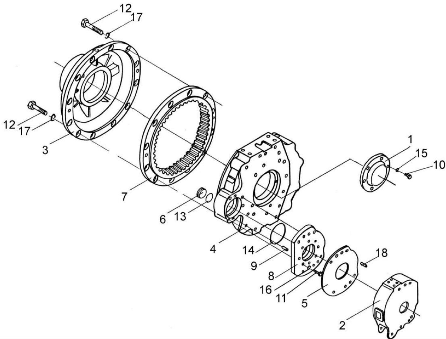
Рисунок 84 – Редуктор бортовой КЗК-10-0107200 (корпуса и крышки)
