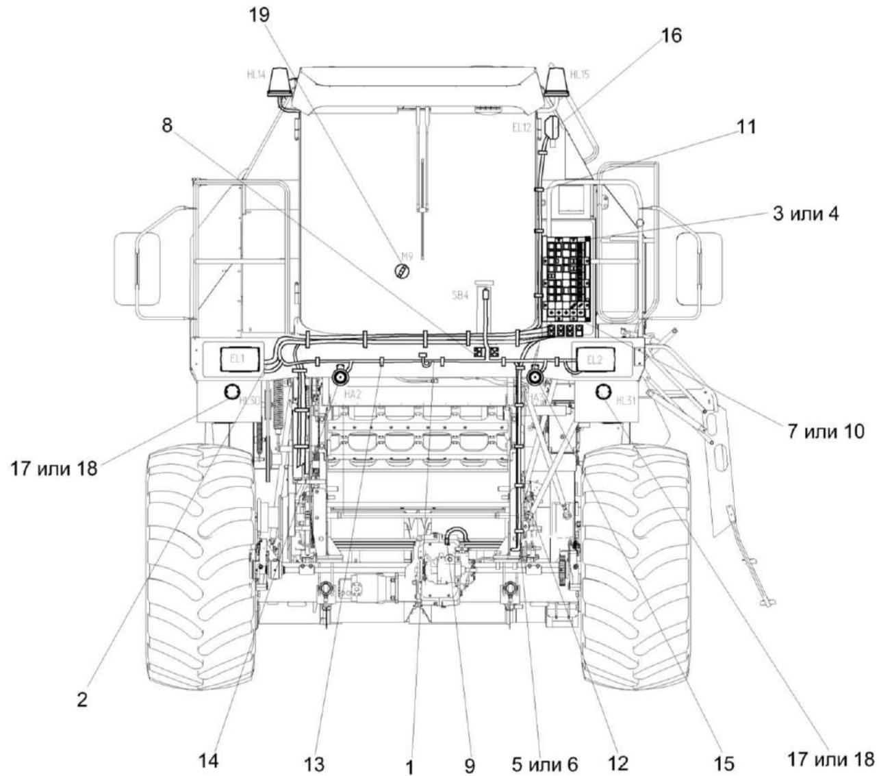
Рисунок 8 – Установка электрооборудования молотилки КЗК-8М-0721000 (вид спереди)
