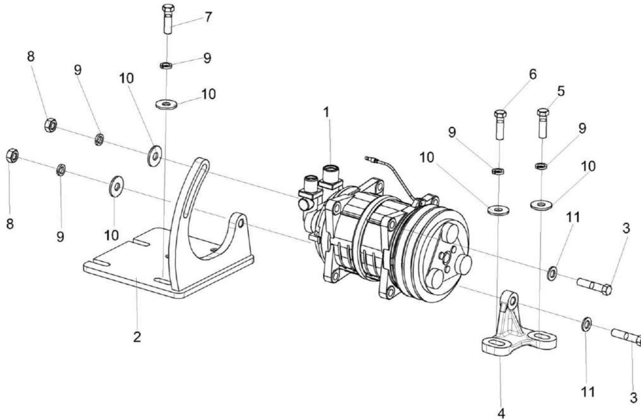
Рисунок 201 – Установка компрессора КЗК-8М-0113030
