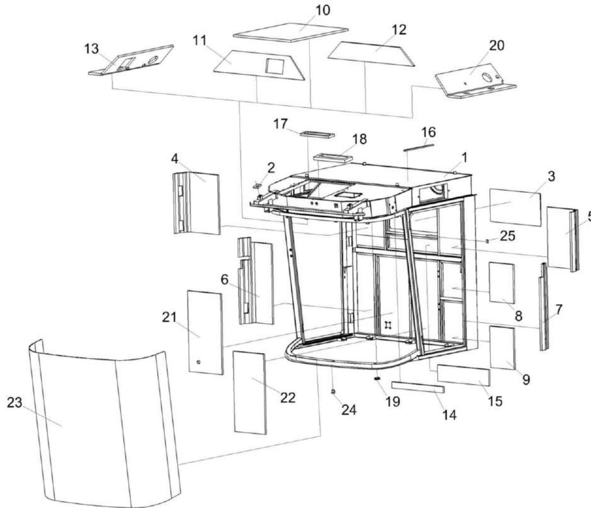
Рисунок 191 – Каркас КЗК-3219-0120020
