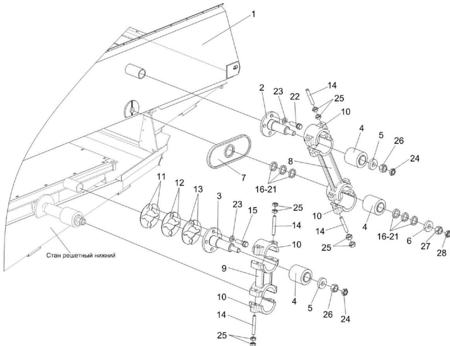
Рисунок 41 – Установка привода стана решетного верхнего КЗК 0260000Б-01
