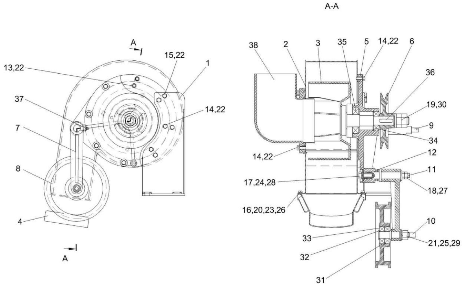
Рисунок 179 – Вентилятор КЗК-8А-0112070
