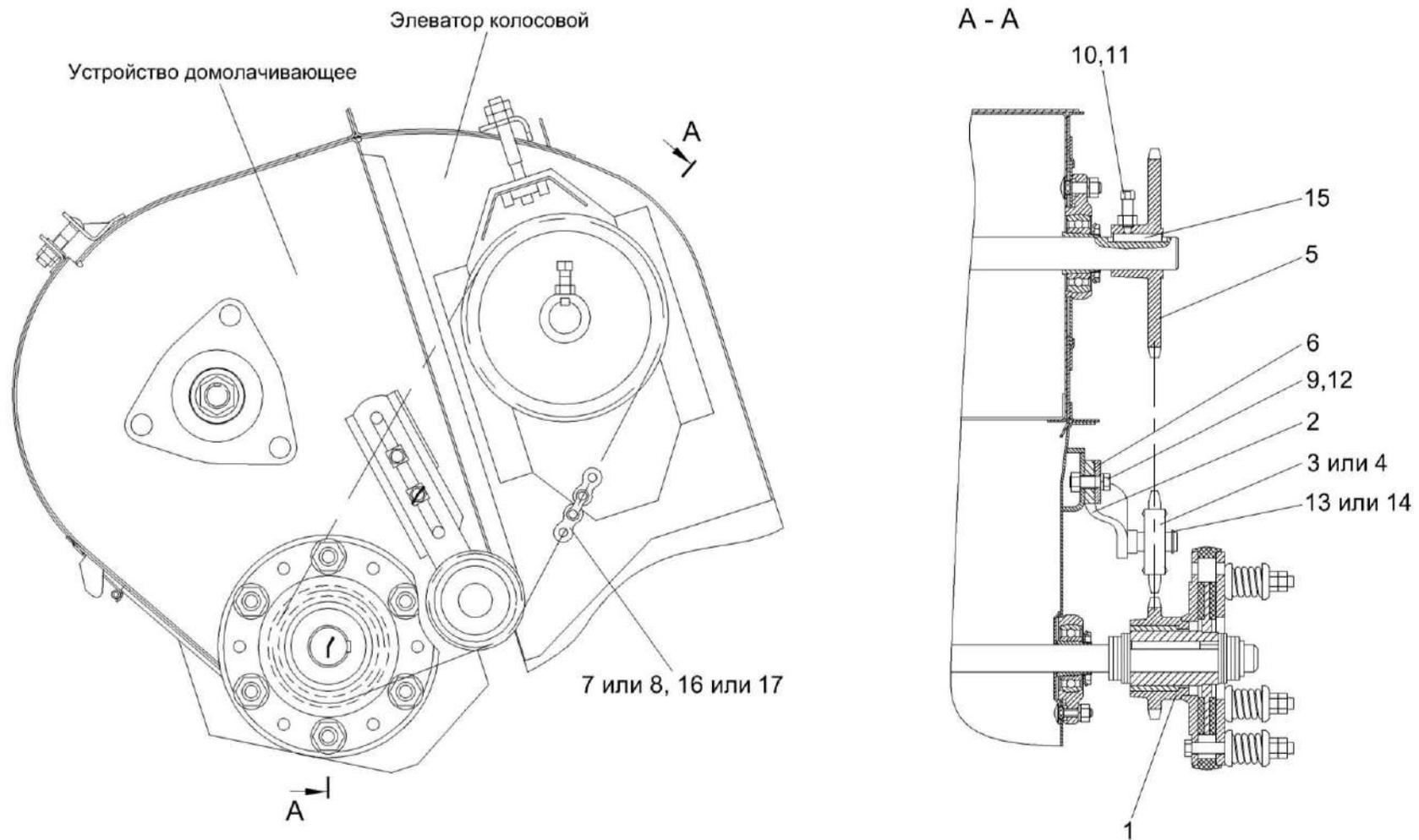
Рисунок 36 – Установка цепного привода элеватора колосового
