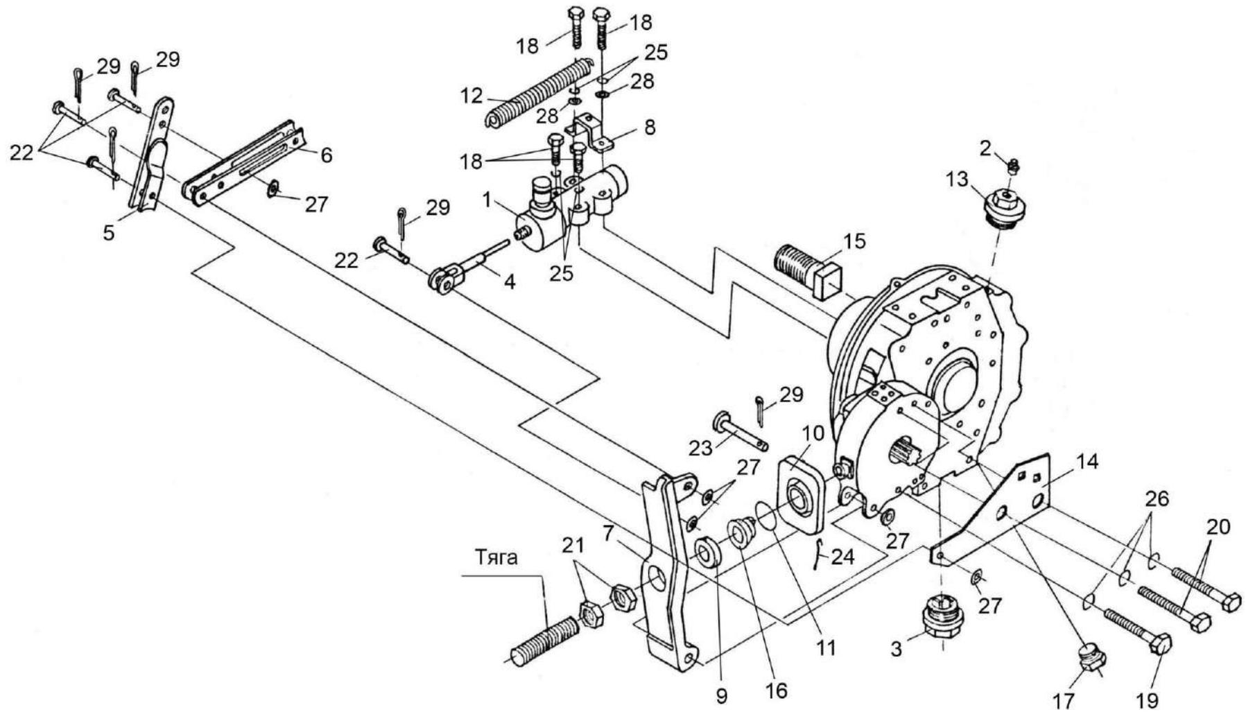
Рисунок 83 – Редуктор бортовой КЗК-10-0107200
