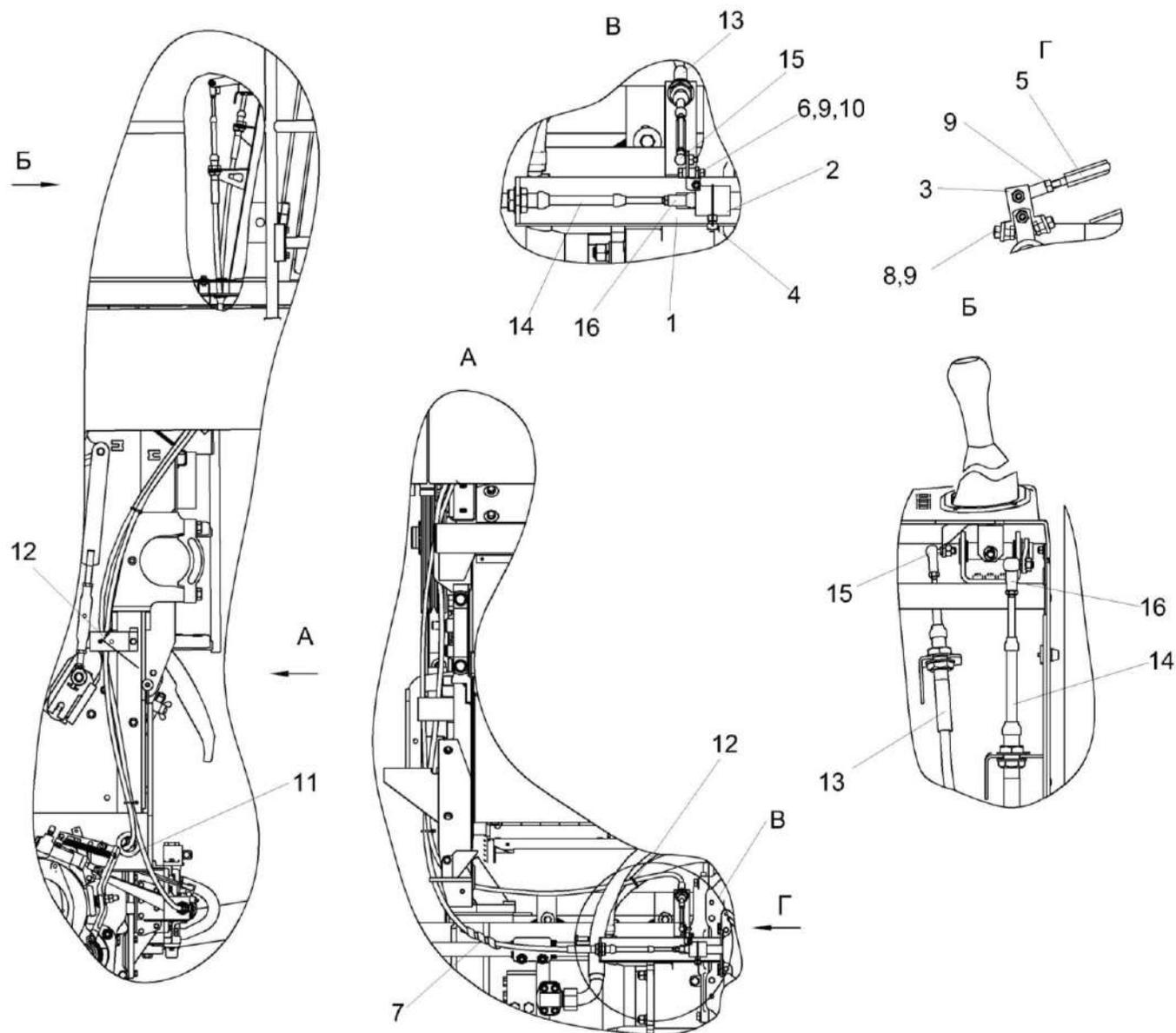
Рисунок 221 – Установка механизма переключения передач КЗК-8М-0119650
