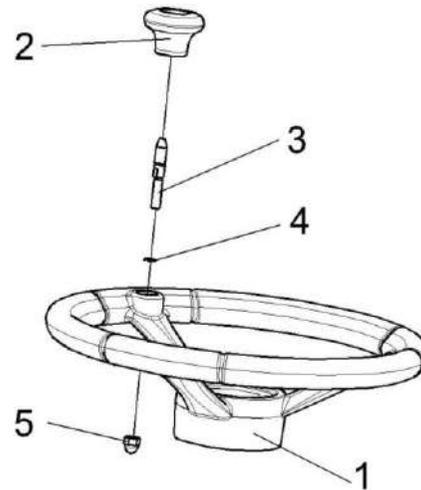
Рисунок 209 – Колесо рулевое КЗК-12-0122300
