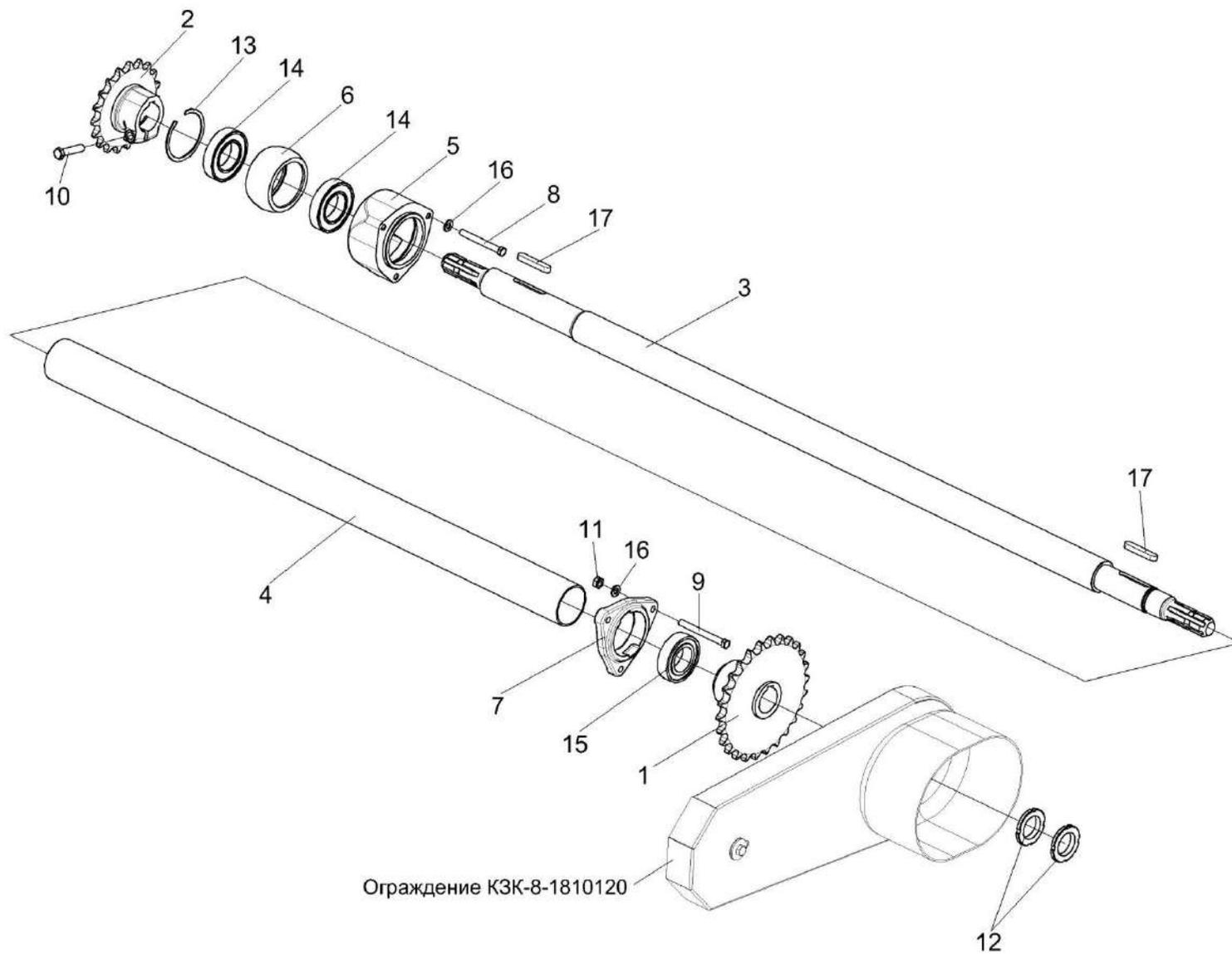
Рисунок 20 – Установка вала КЗК-8-1810602
