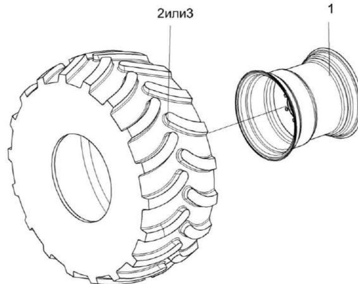
Рисунок 107 – Колесо УЭС-7-0110000 и УЭС-7-0110000-02
