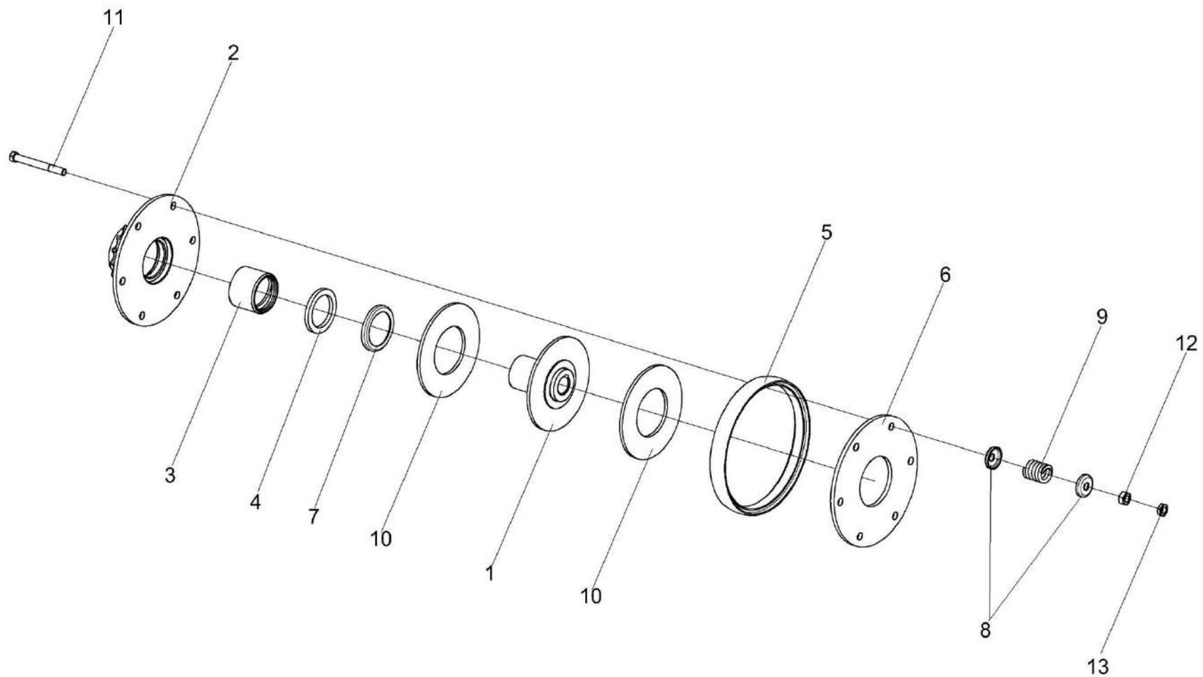
Рисунок 61 – Муфта фрикционная КЗК 0219020Б-01
