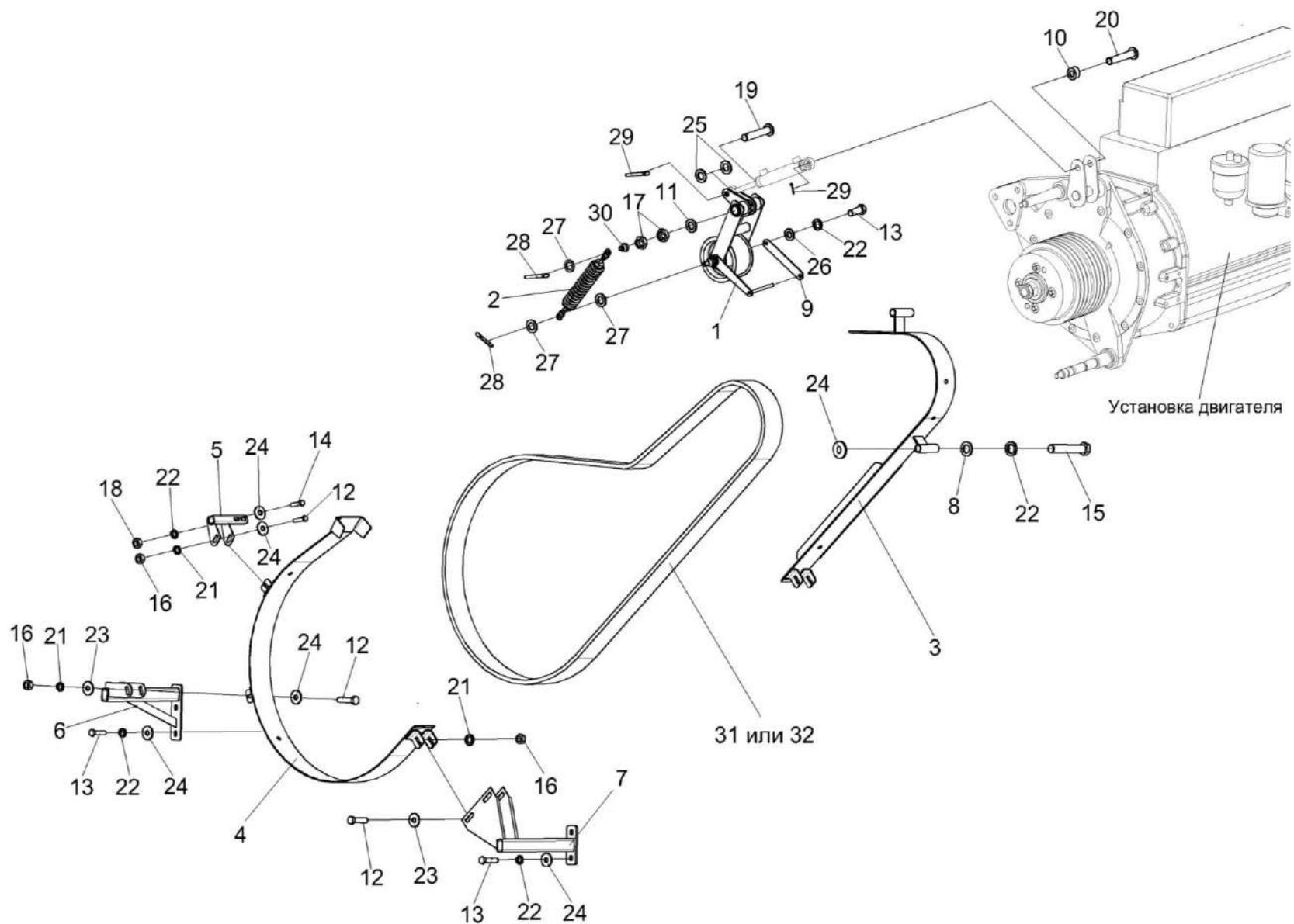
Рисунок 180 – Привод главного контрпривода КЗК 0220000А
