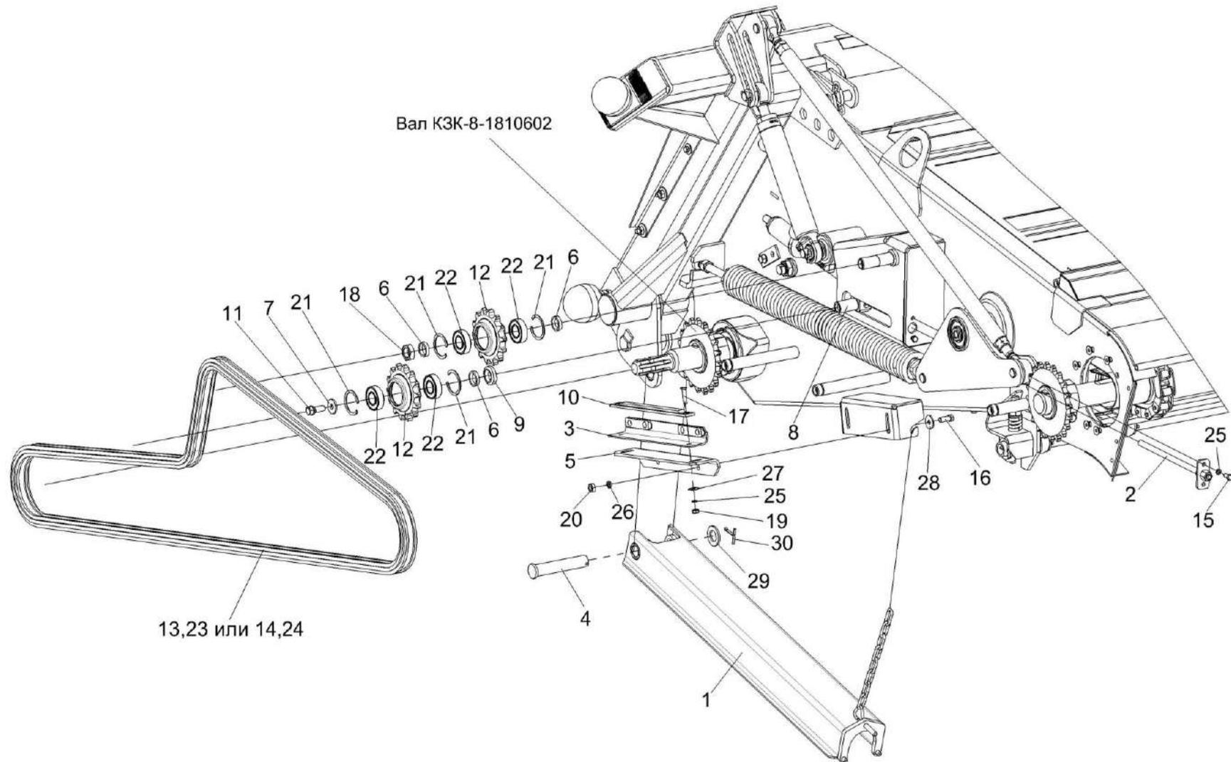
Рисунок 19 – Камера наклонная. Привод транспортера
