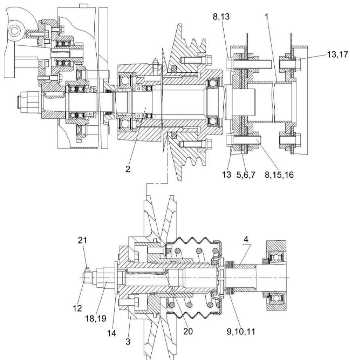
Рисунок 42 – Очистка, шкив ведомый КЗК-12-0217400 и контрпривод вариатора КЗК-7-0202500Б
