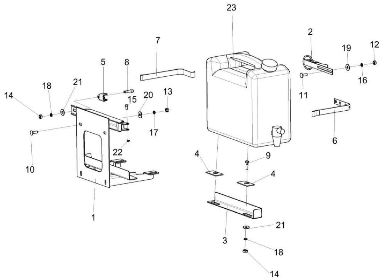
Рисунок 198 – Установка бачка КЗК-8М-0100100
