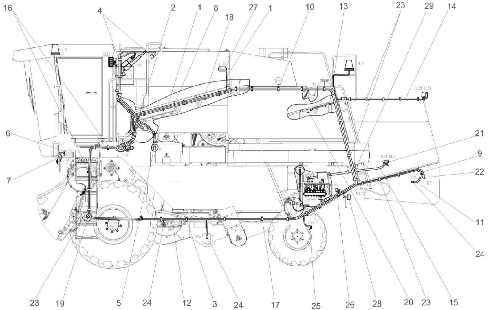
Рисунок 5 – Установка электрооборудования молотилки КЗК-8М-0721000 (вид слева)
