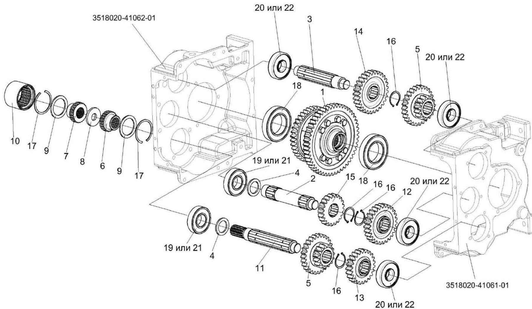
Рисунок 92 – Коробка передач КЗК-8-4-0107030 (валы, шестерни)
