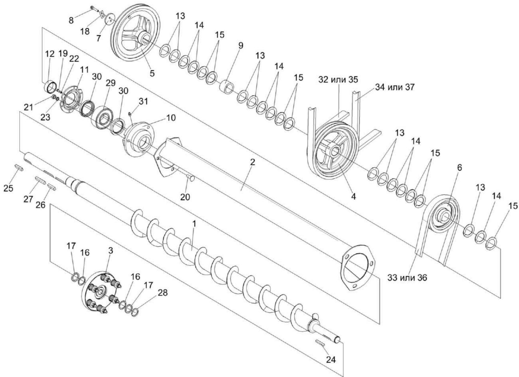
Рисунок 34 – Установка шкивов на шнек распределительный КЗК 0202770В
