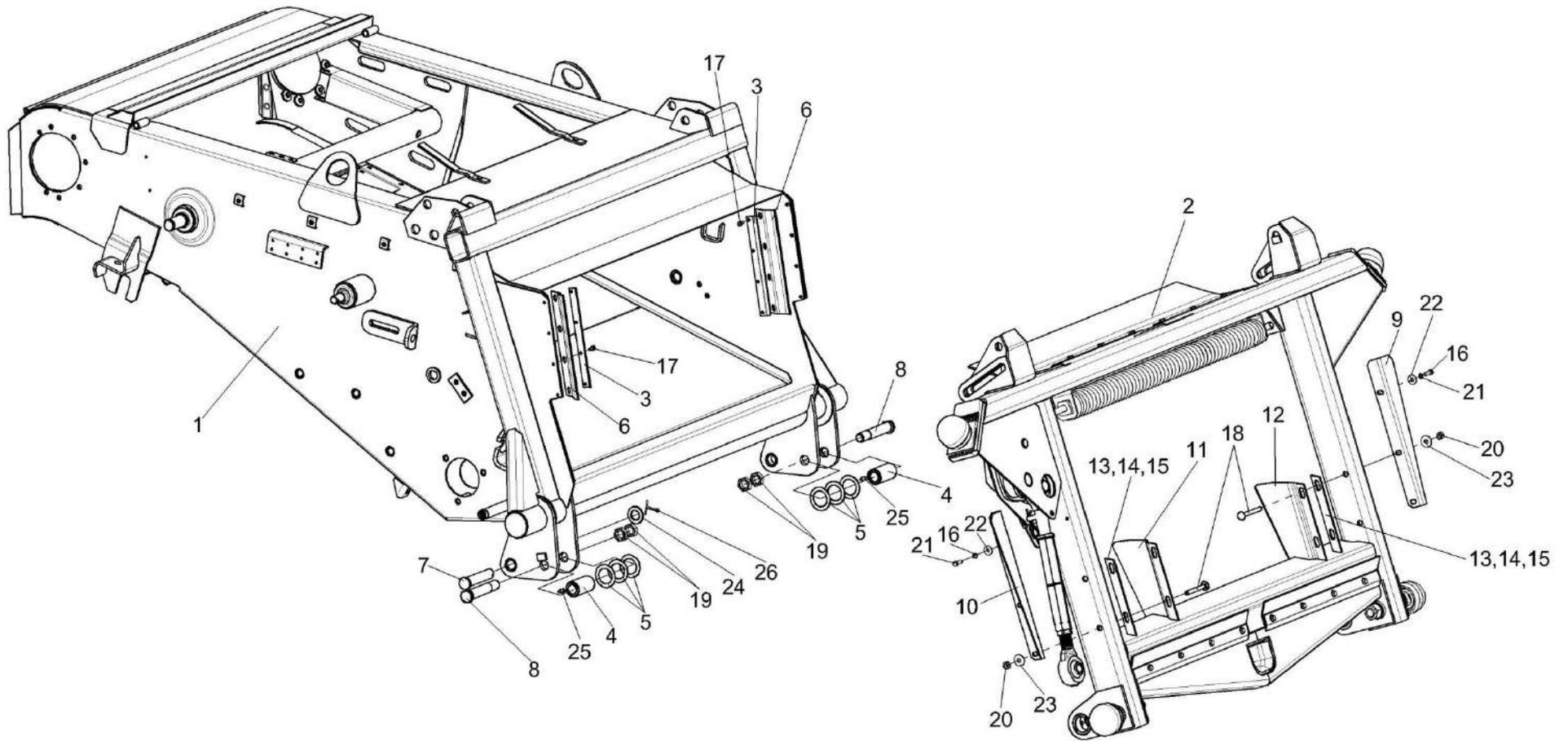
Рисунок 25 – Установка рамки переходной КЗК 1780000А
