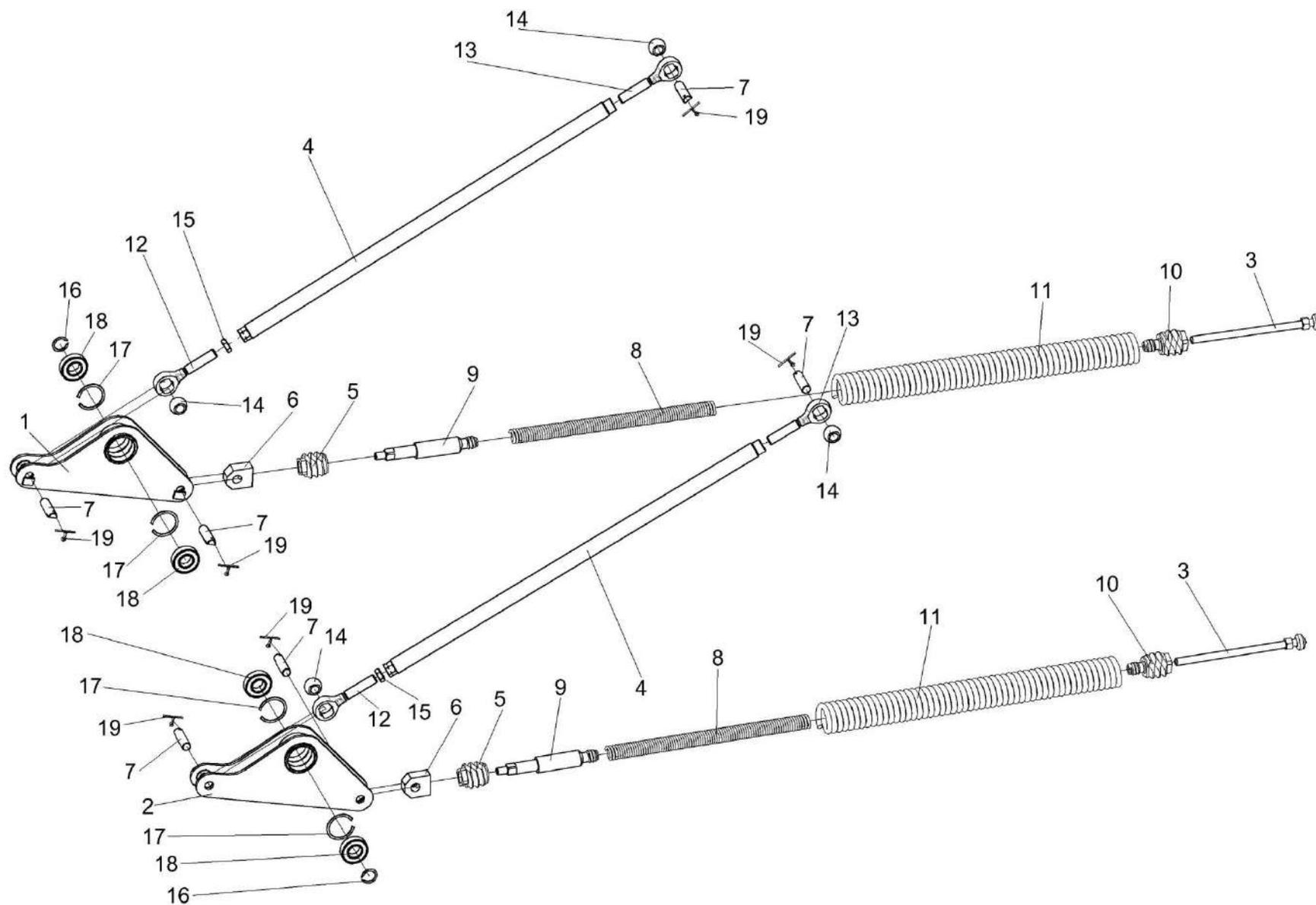
Рисунок 23 – Механизм продольного копирования КЗК 1775000А
