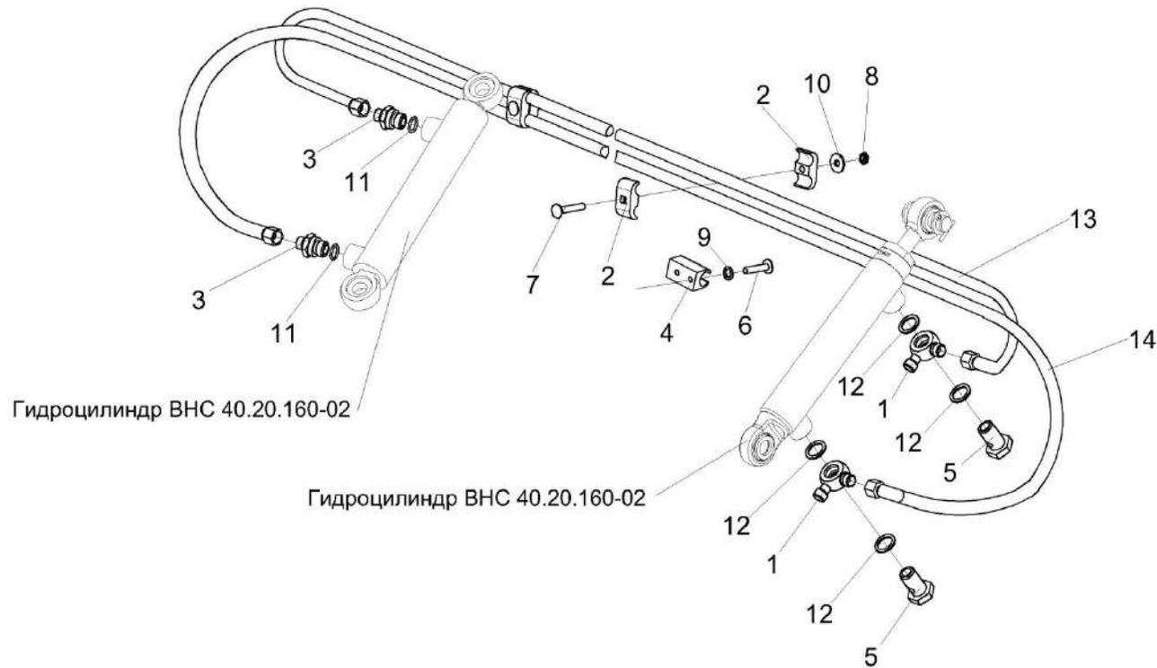
Рисунок 28 – Система гидравлическая КЗК 1790000
