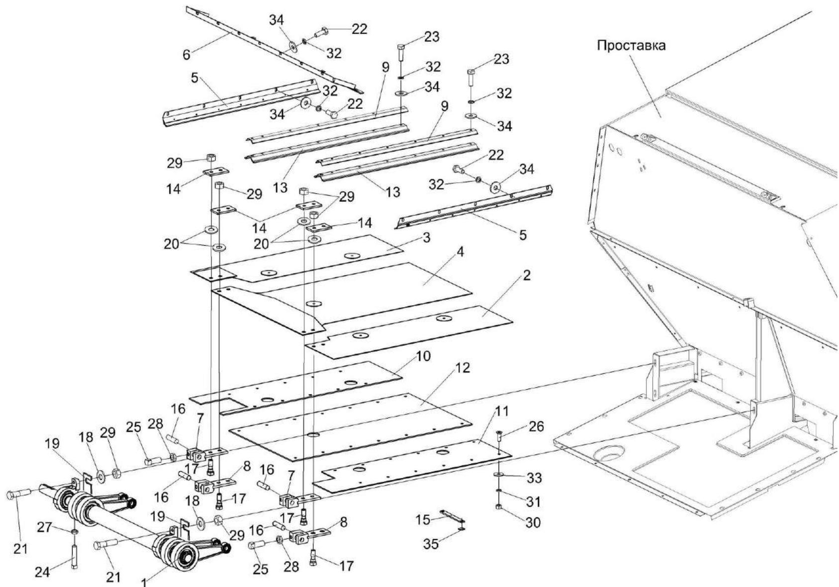
Рисунок 128 – Установка виброна КЗК-7-0226000
