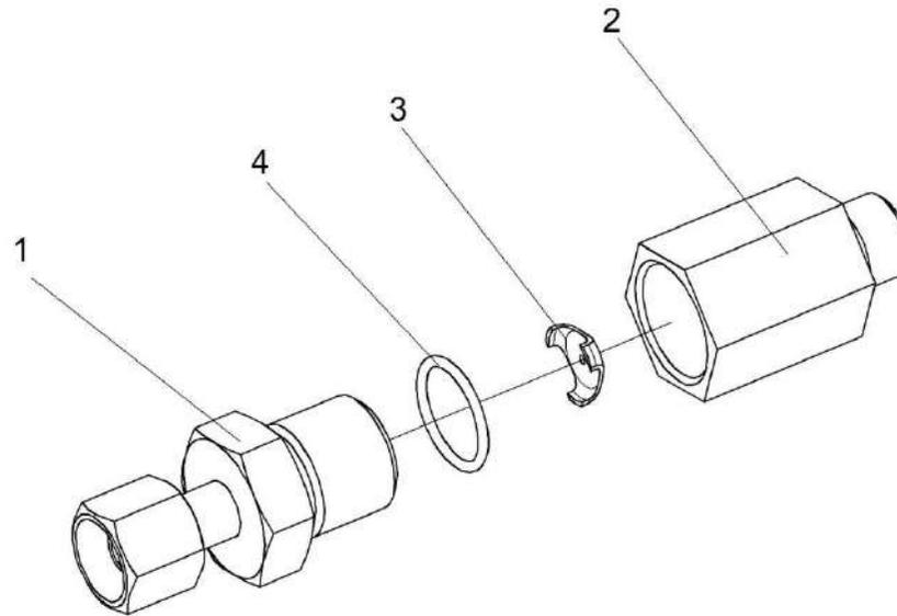
Рисунок 247 – Дроссель с обратным клапаном КЗК 0602520А-01
