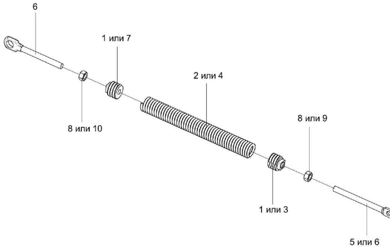
Рисунок 136 – Пружины КЗК 0100720 и КЗР 0202800А
