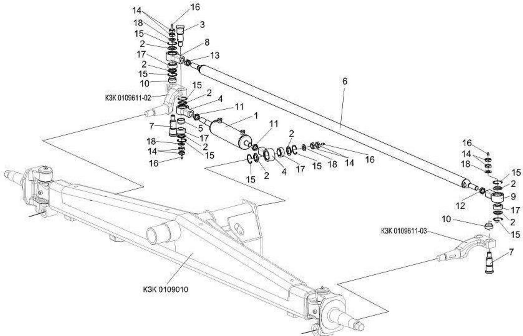
Рисунок 98 – Мост управляемых колес КЗК 0109000 (лист 2)
