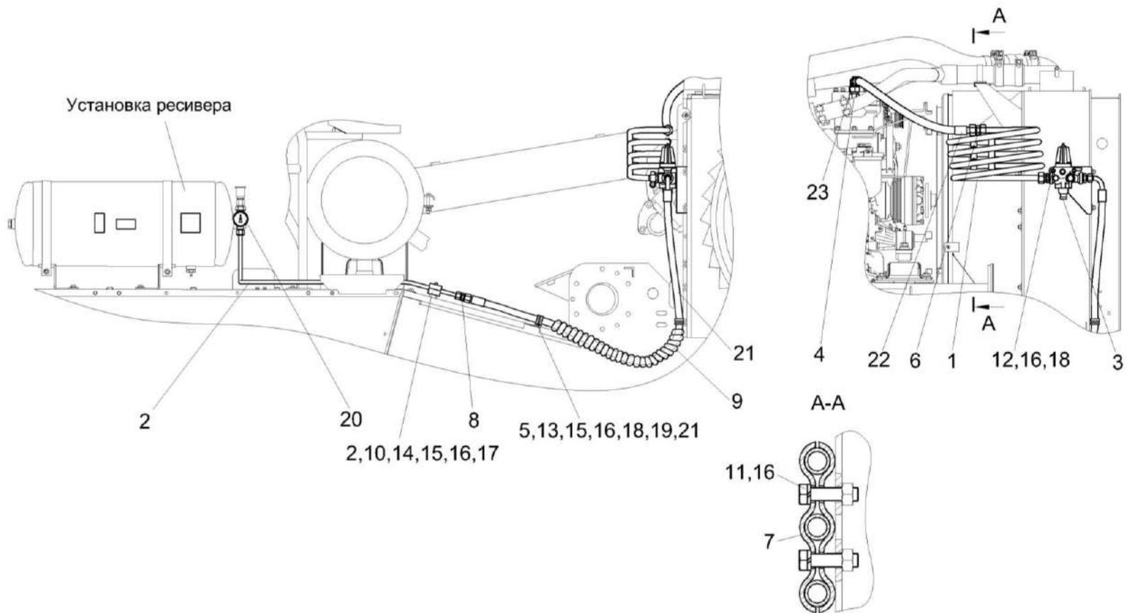
Рисунок 256 – Пневмосистема КЗК-812С-2-0800000
