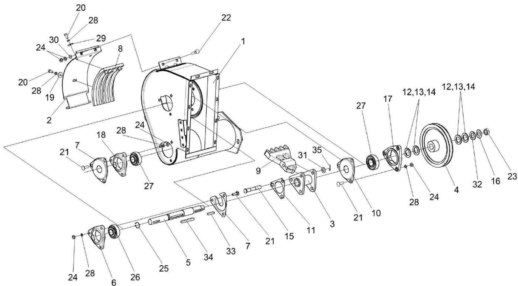
Рисунок 58 – Устройство домолачивающее КЗК 0207000В
