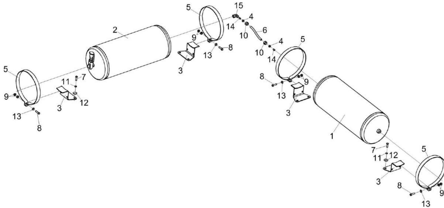
Рисунок 229 – Установка ресиверов КЗК-8А-10-2-0800010
