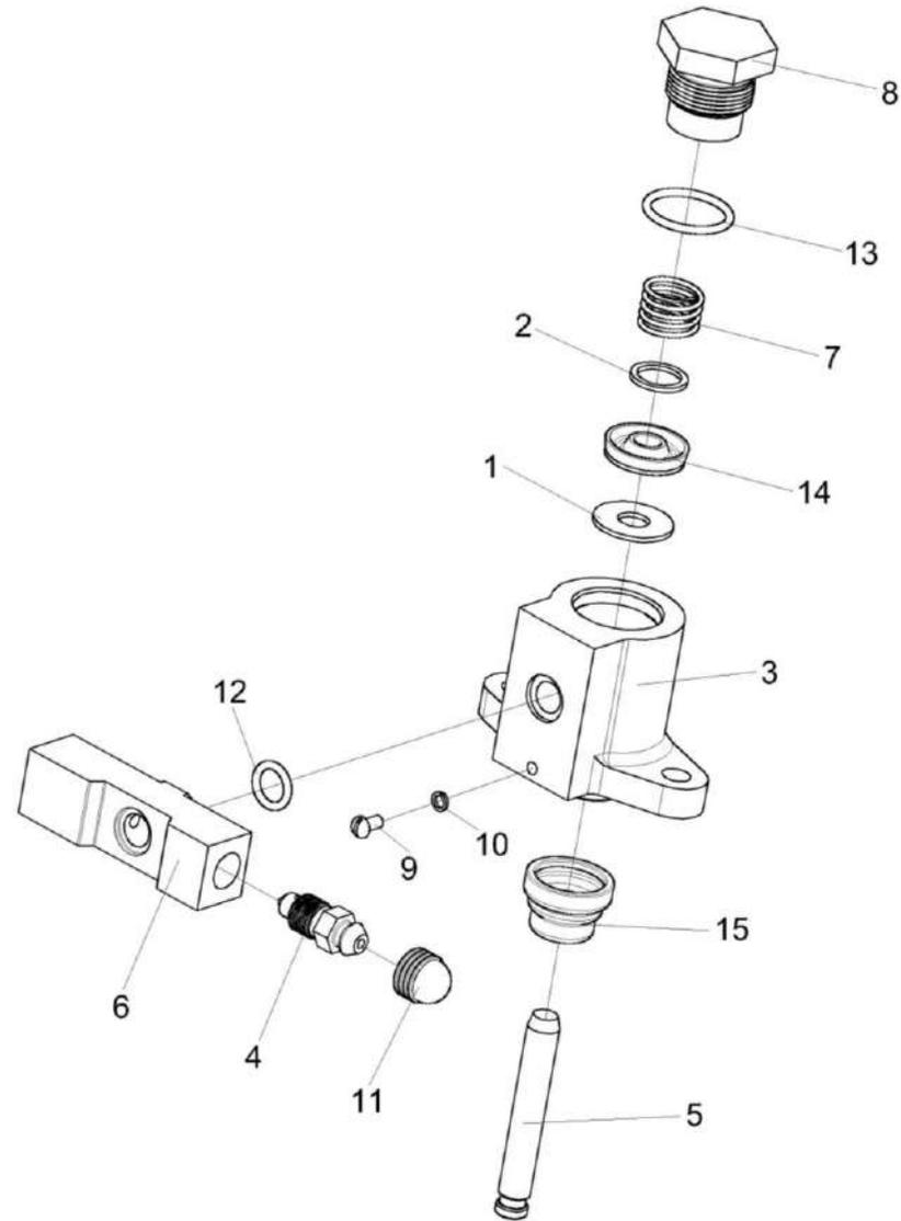
Рисунок 95 – Гидроцилиндр КЗК-12-0107200-01
