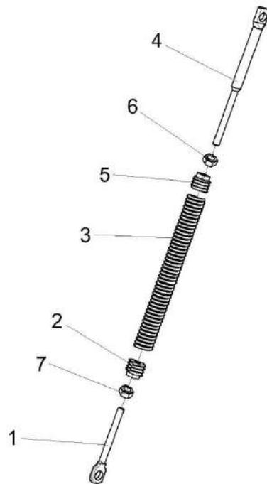
Рисунок 56 – Пружина КЗК 0202850А-02
