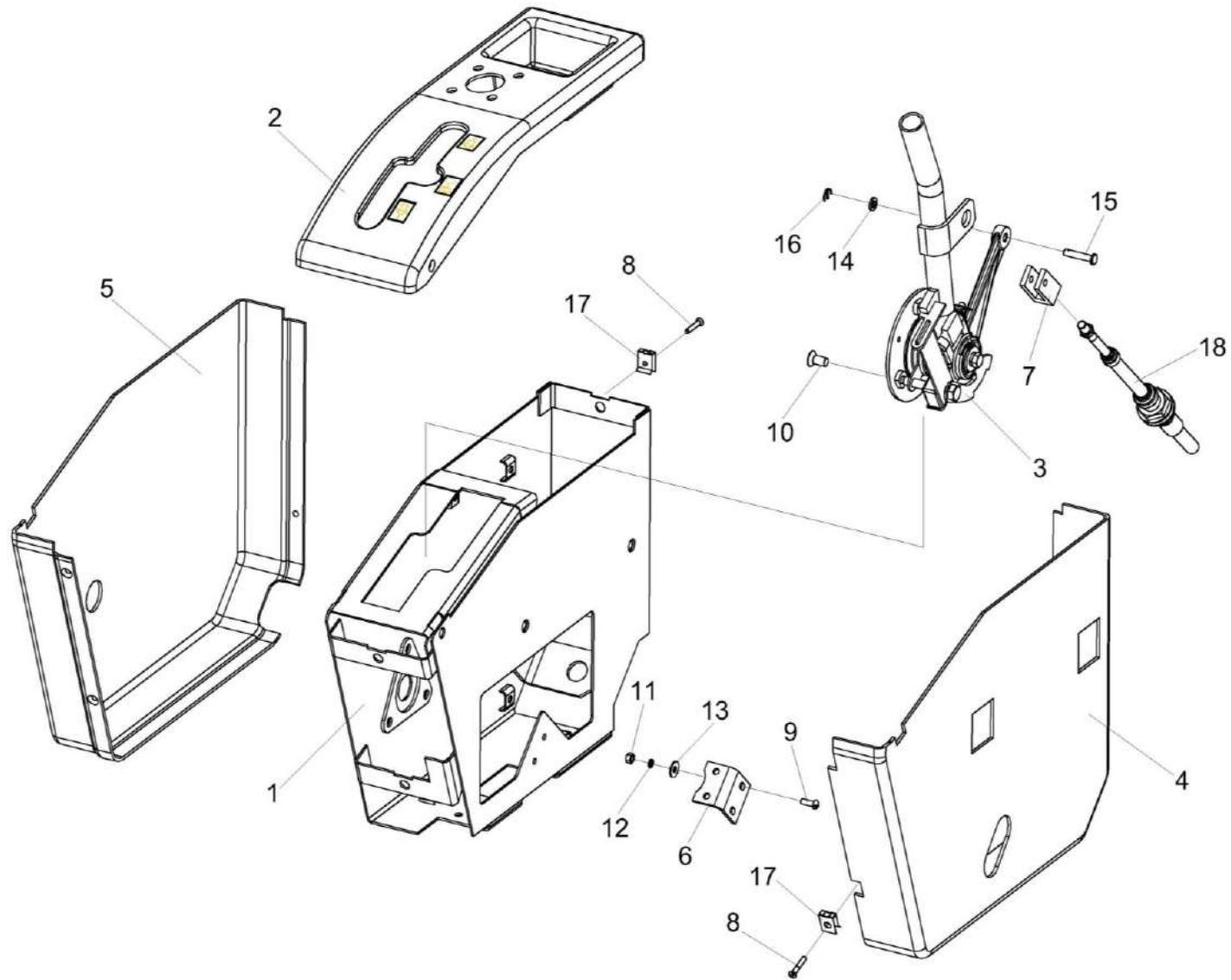
Рисунок 213 – Блок управления КЗК-3219-0119890
