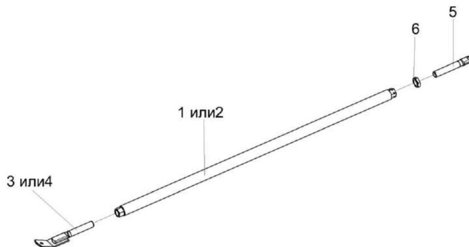
Рисунок 121 – Раскосы КЗК 0216200Б и КЗК 0216200Б-01
