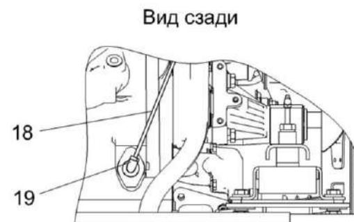
Рисунок 164 – Установка пневмокомпрессора КЗК-812С-3-0106900
