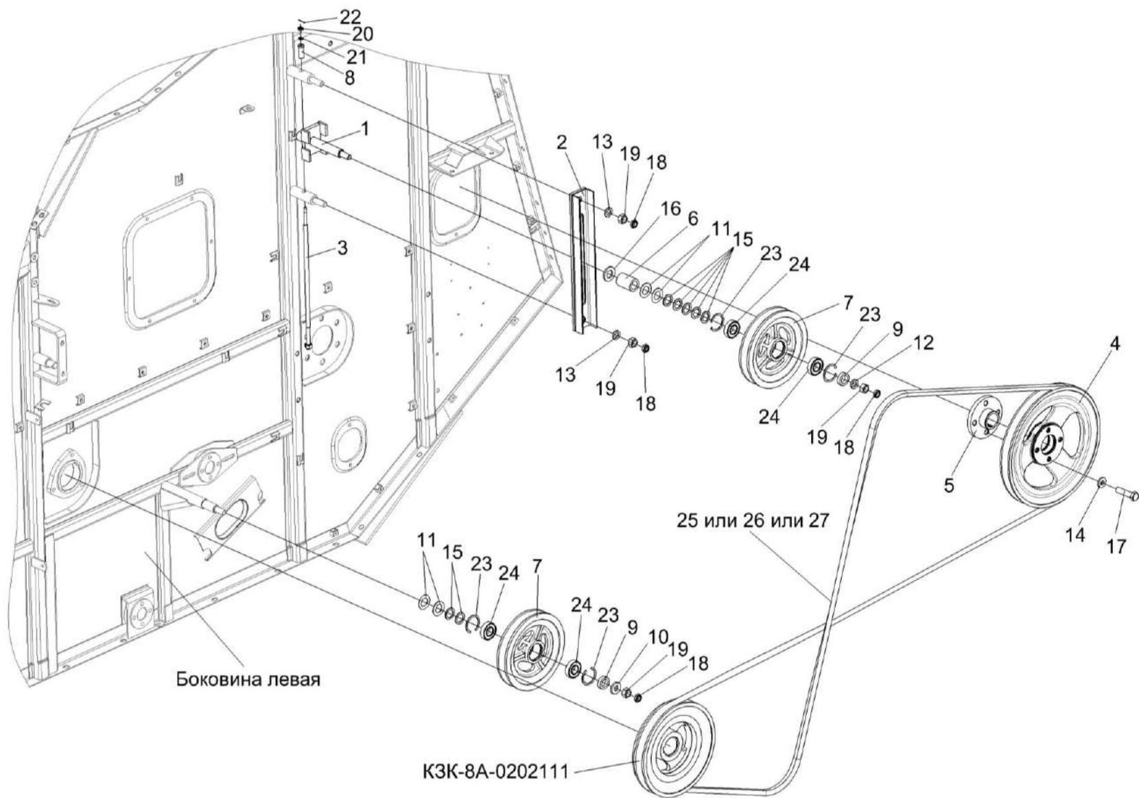
Рисунок 38 – Установка привода солоотряса
