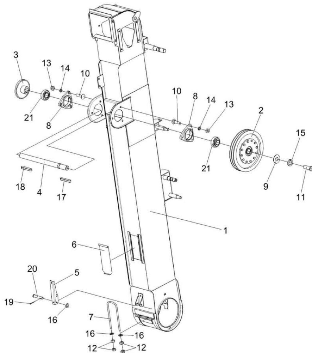
Рисунок 113 – Элеватор зерновой КЗК 0214000Б-02 (лист 2)
