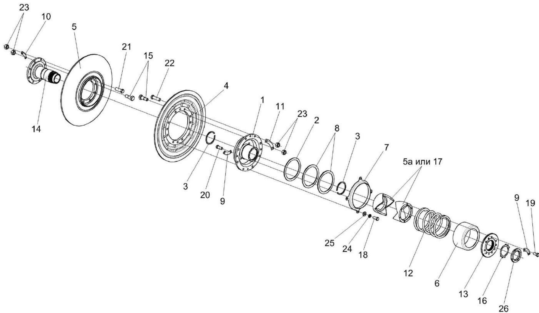
Рисунок 79 – Вариатор барабана КЗК 0123000
