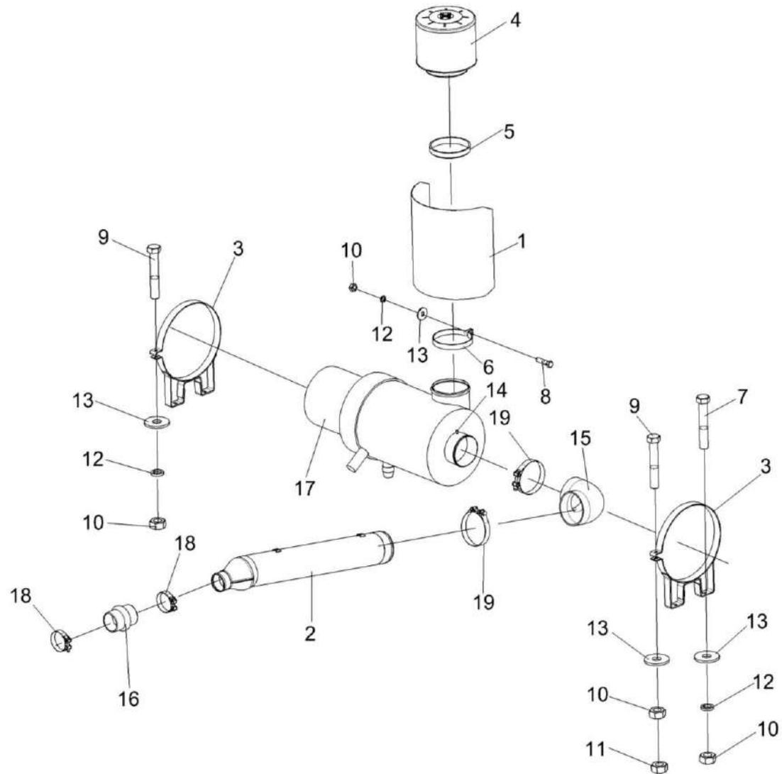
Рисунок 175 – Установка воздухоочистителя КЗК-8А-2-0106080
