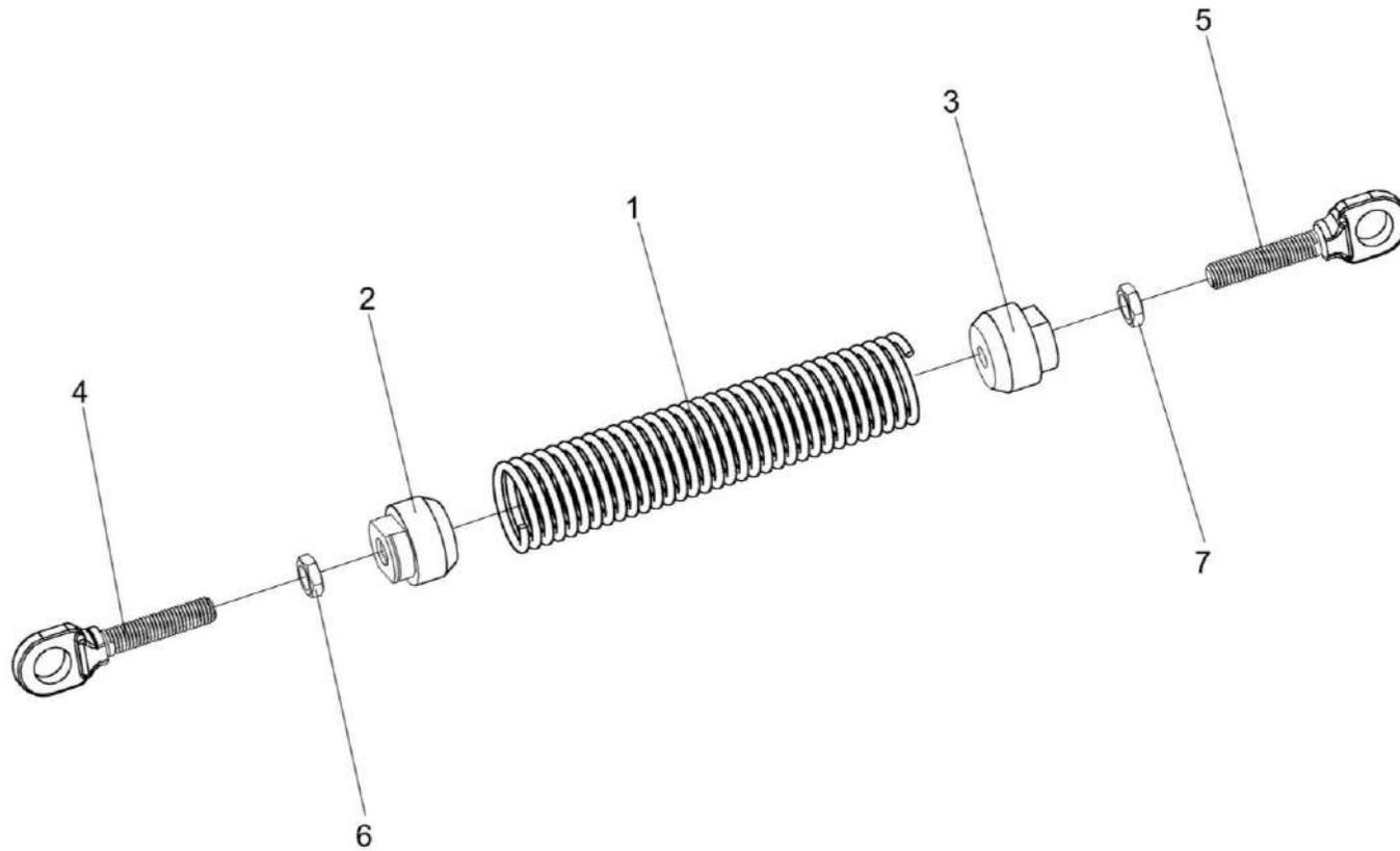
Рисунок 163 – Пружины КЗС 0131210 и КЗС 0131210-01
