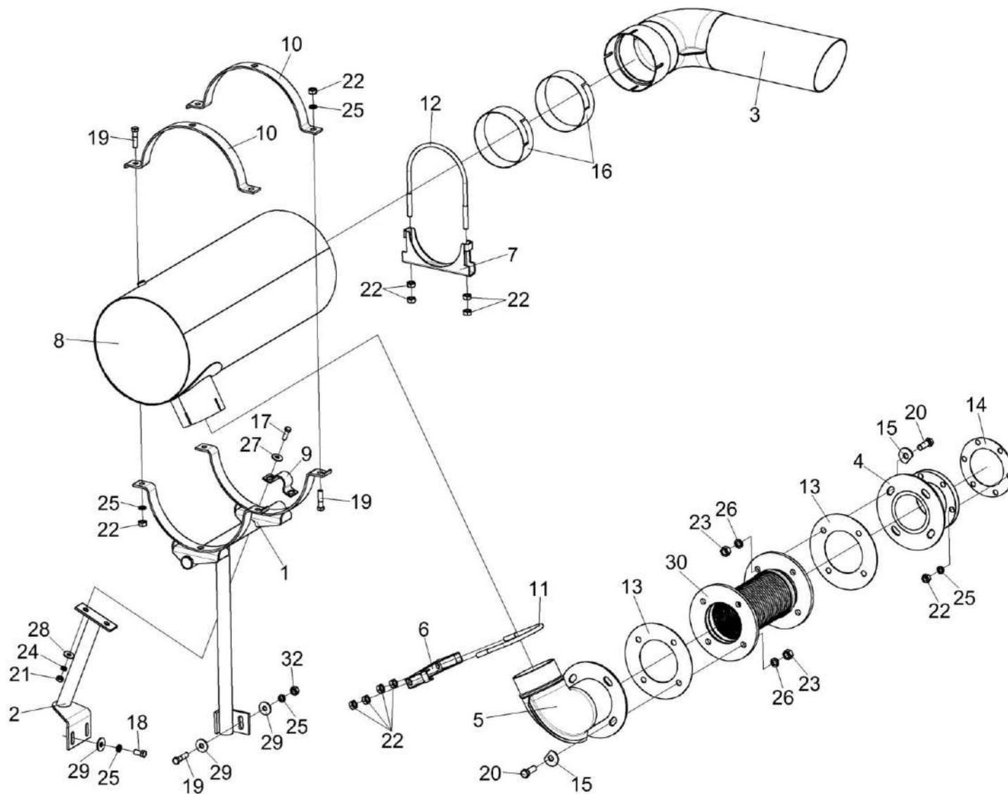
Рисунок 165 – Установка глушителя КЗК-8К-0106060
