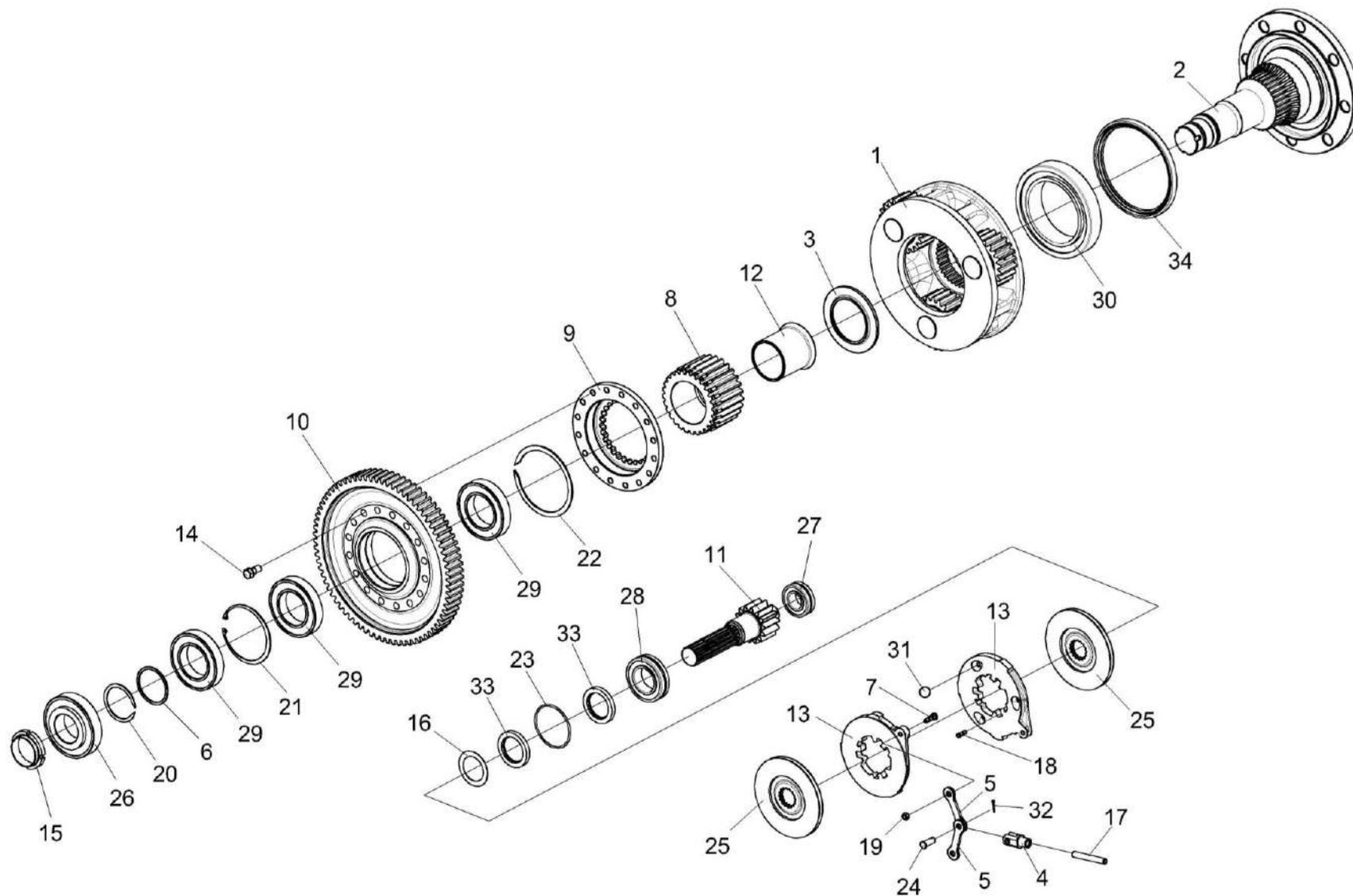
Рисунок 88 – Редуктор бортовой КЗК-10-0107200-01 (валы и шестерни)
