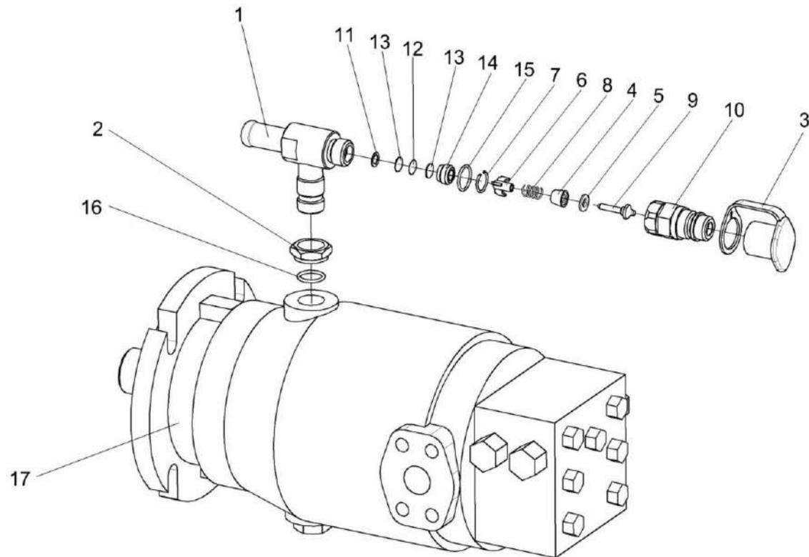
Рисунок 255 – Гидромотор КЗК-12-0601500-01
