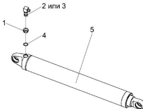
Рисунок 253 – Гидроцилиндр КЗК 0602290-01
