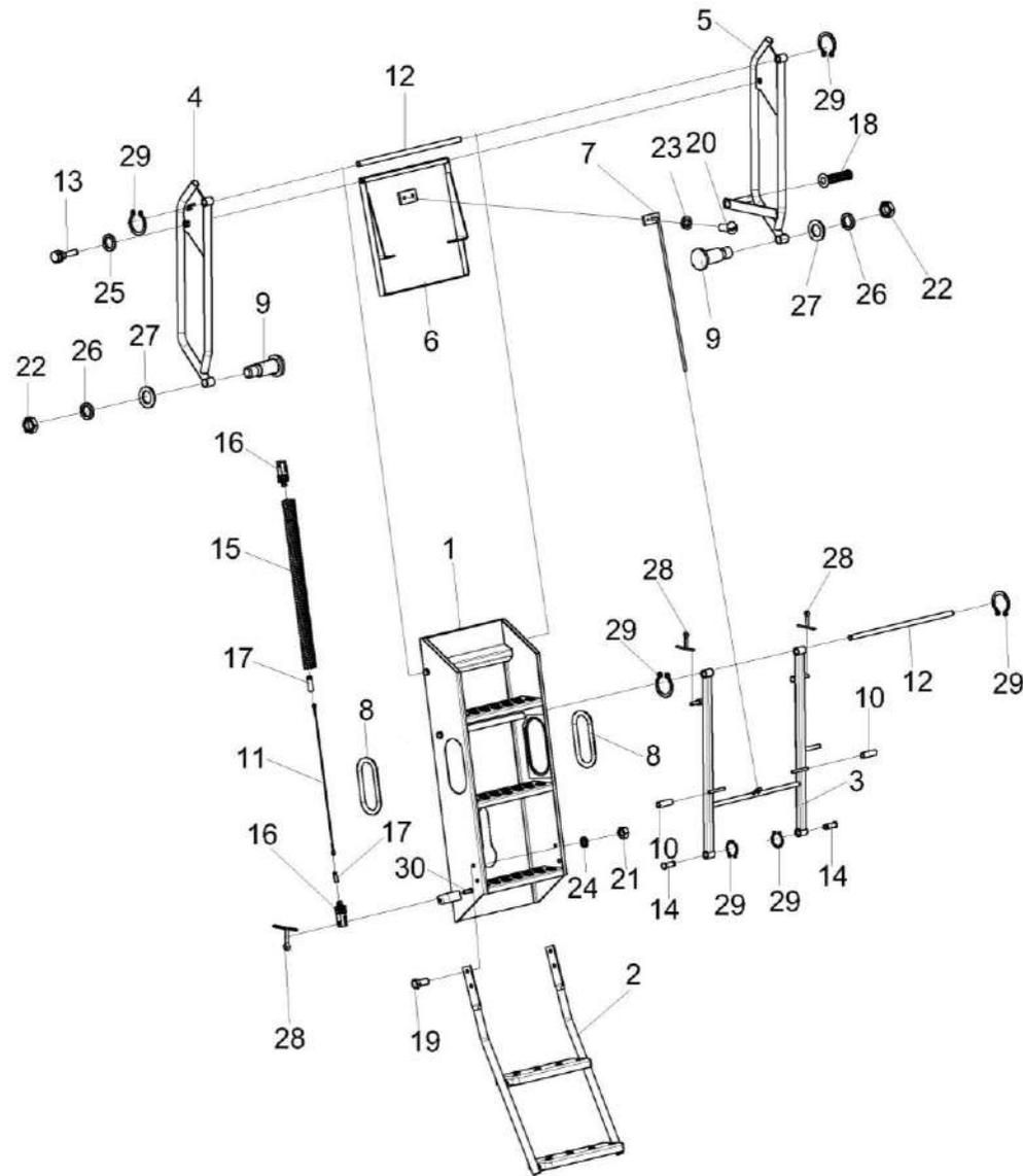
Рисунок 234 – Установка трапа КЗК-7-0117000
