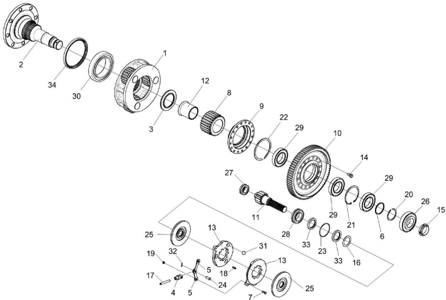
Рисунок 85 – Редуктор бортовой КЗК-10-0107200 (валы и шестерни)
