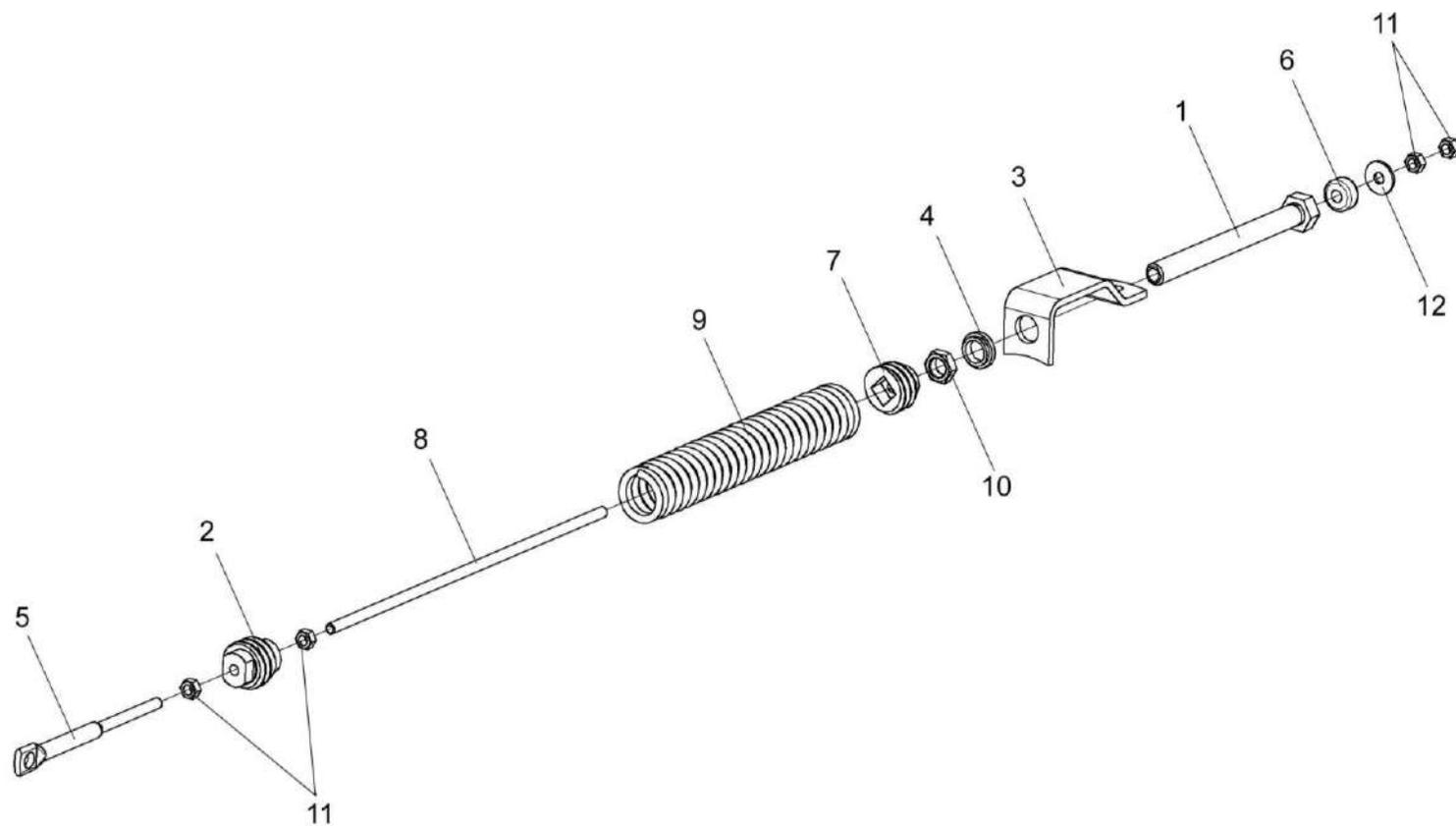
Рисунок 109 – Пружина КЗК 0100580А
