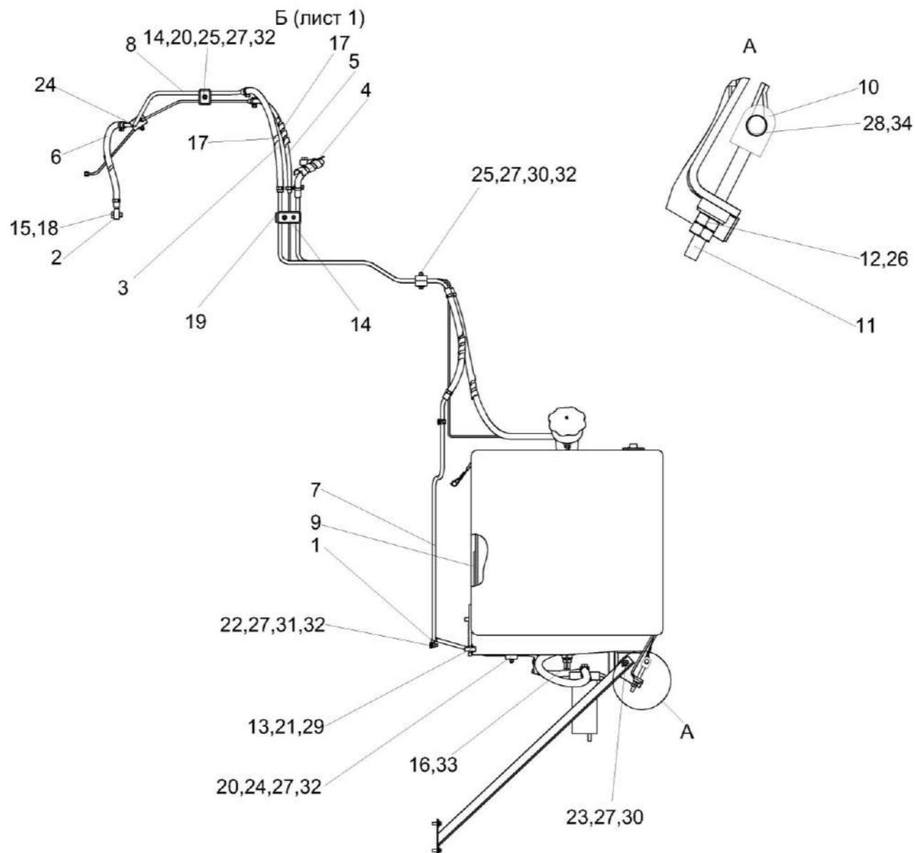
Рисунок 185 – Установка топливного оборудования КЗК-8К-0126000 (лист 2)
