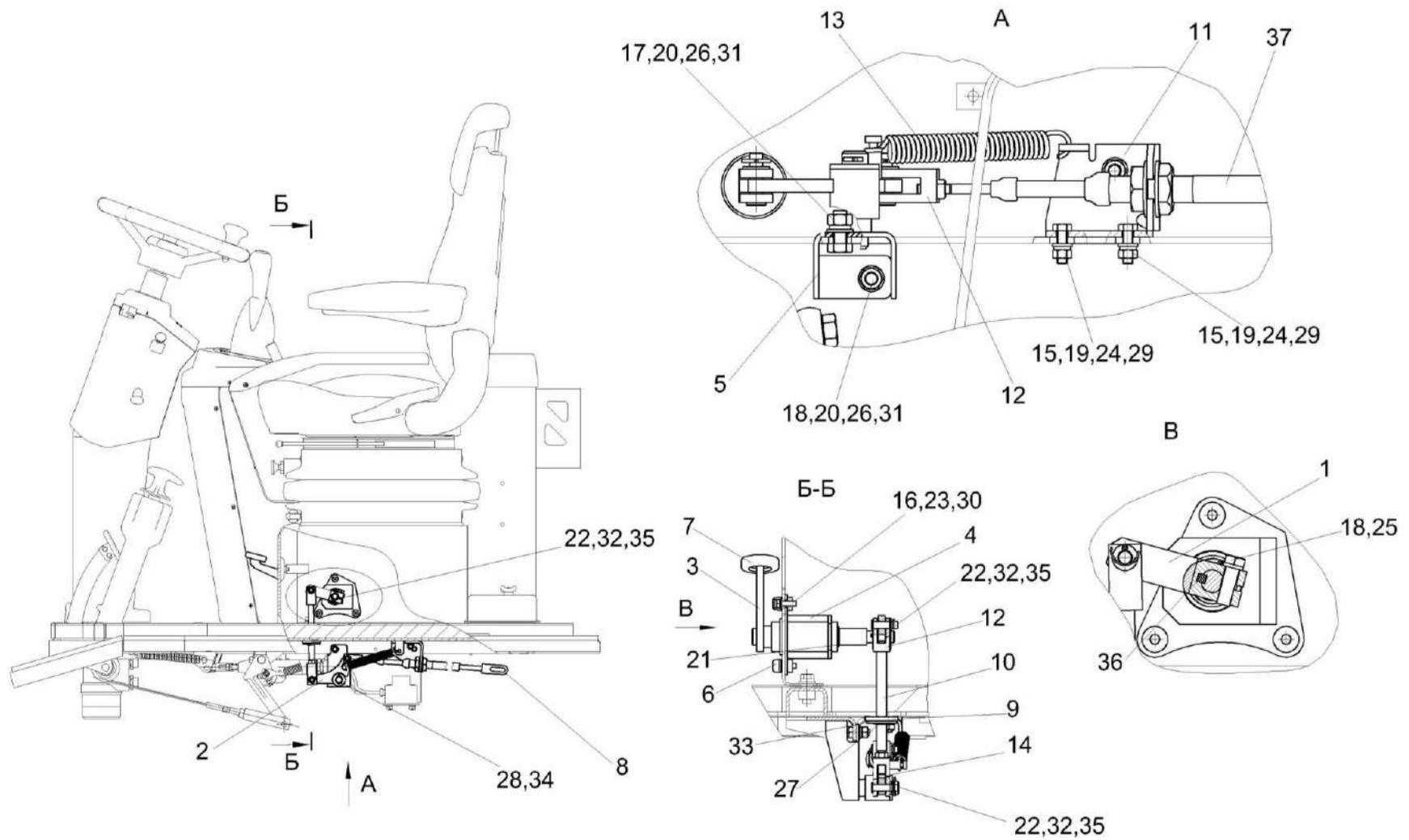
Рисунок 218 – Установка привода механизма сброса подбарабannya КЗК-8М-01 19060
