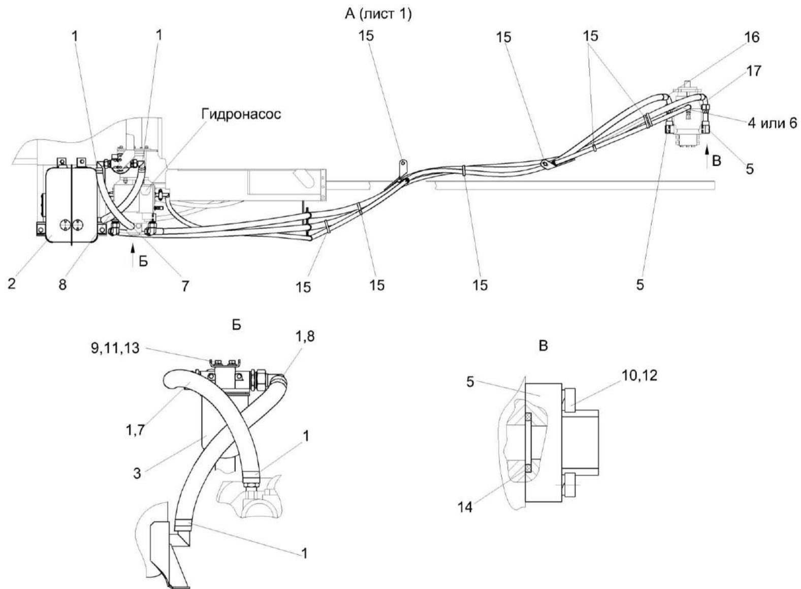
Рисунок 238 – Гидросистема привода ходовой части КЗК-8А-0601000-01 (лист 2)
