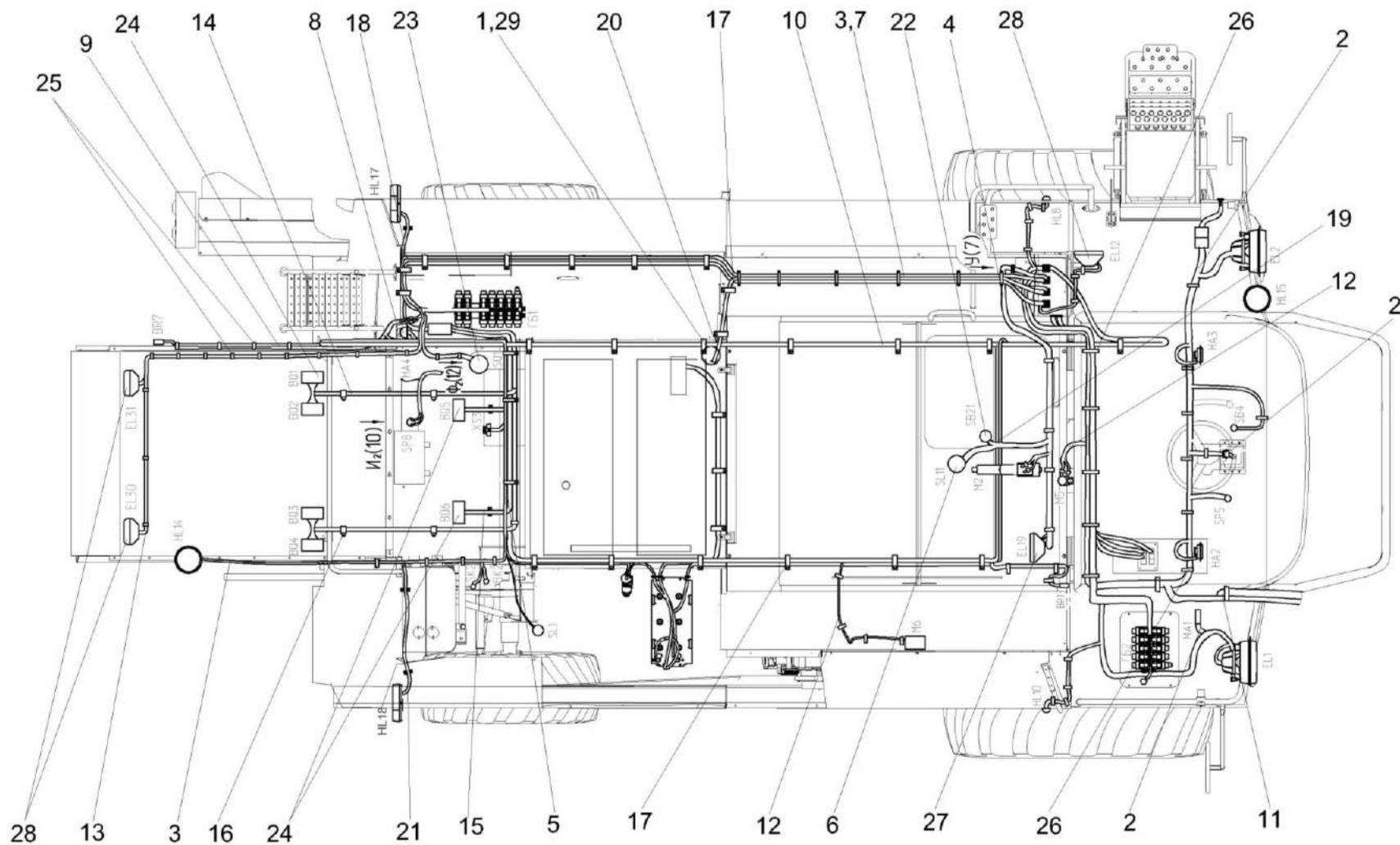
Рисунок 7 – Установка электрооборудования молотилки КЗК-8М-0721000 (вид сверху)
