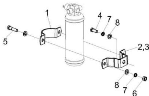
Рисунок 202 – Установка ресивера КЗК-8-3-0113050
