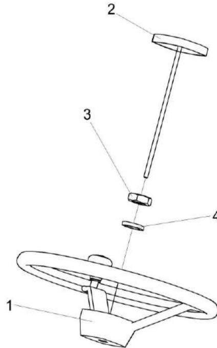
Рисунок 208 – Установка колеса рулевого КЗК-12-0122600-02
