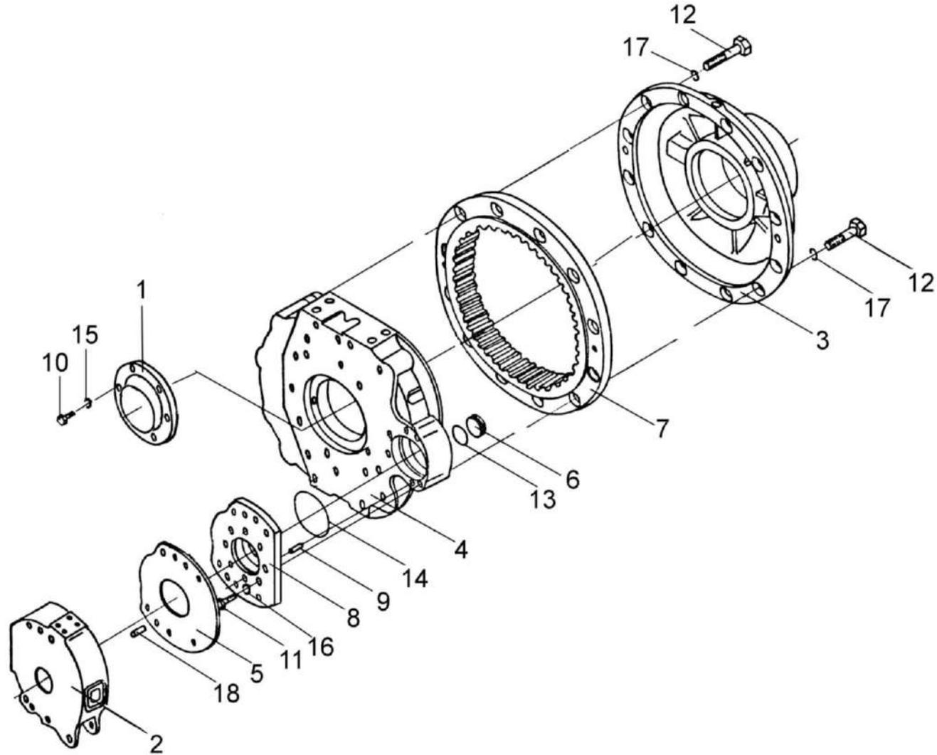
Рисунок 87 – Редуктор бортовой КЗК-10-0107200-01 (корпуса и крышки)
