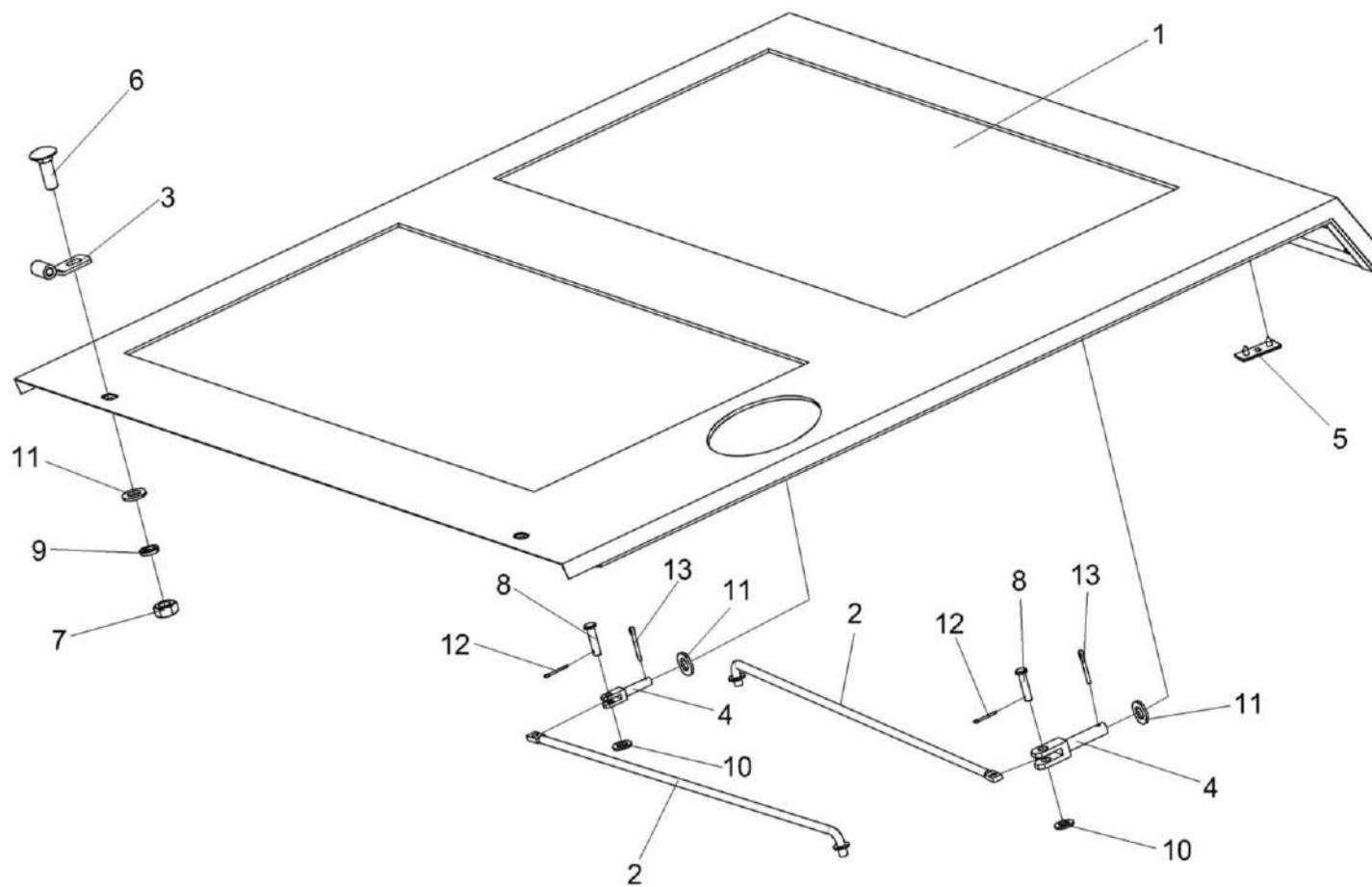
Рисунок 233 – Крыша КЗК-8А-2-0124000
