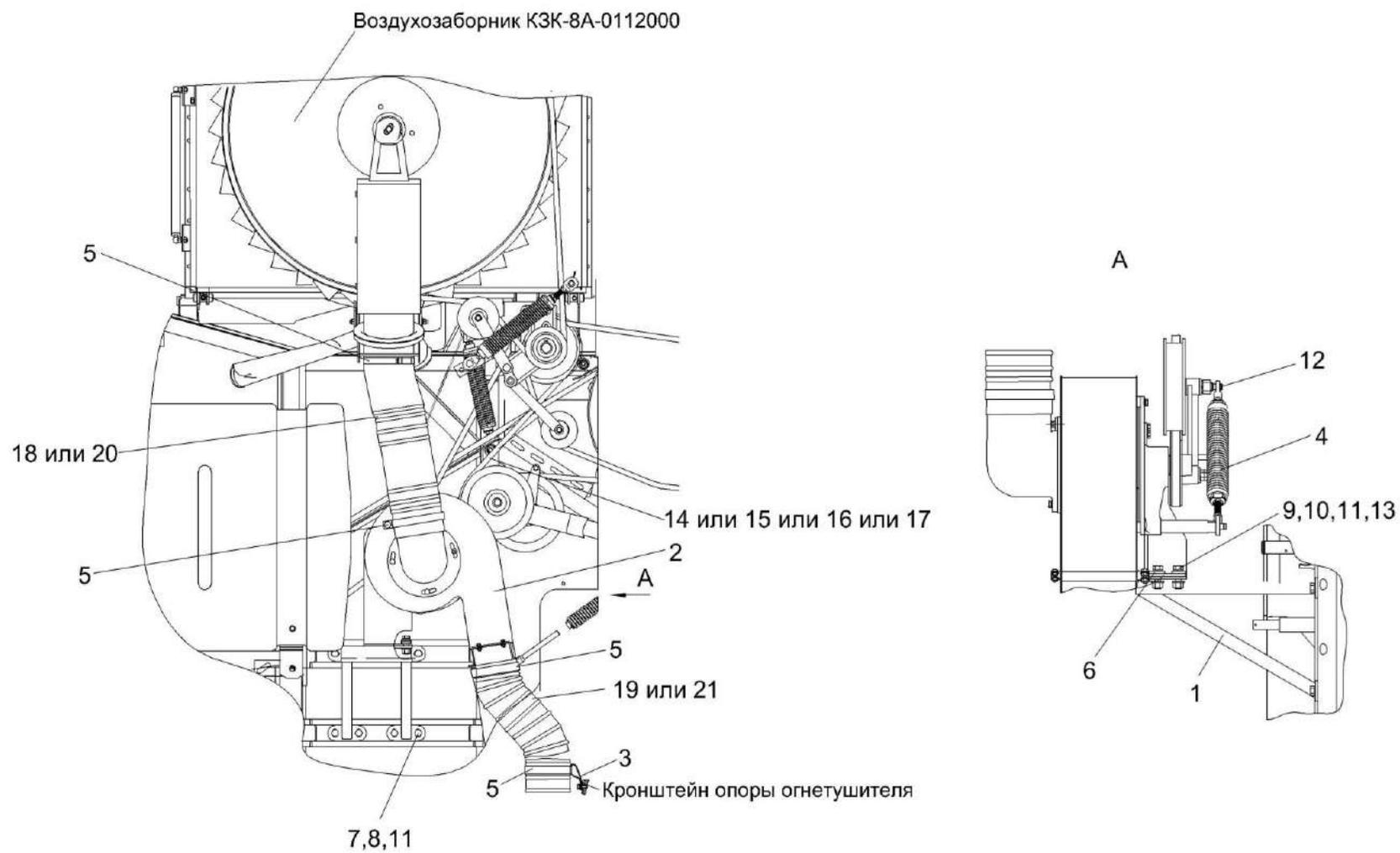
Рисунок 178 – Установка вентилятора КЗК-8А-0112100
