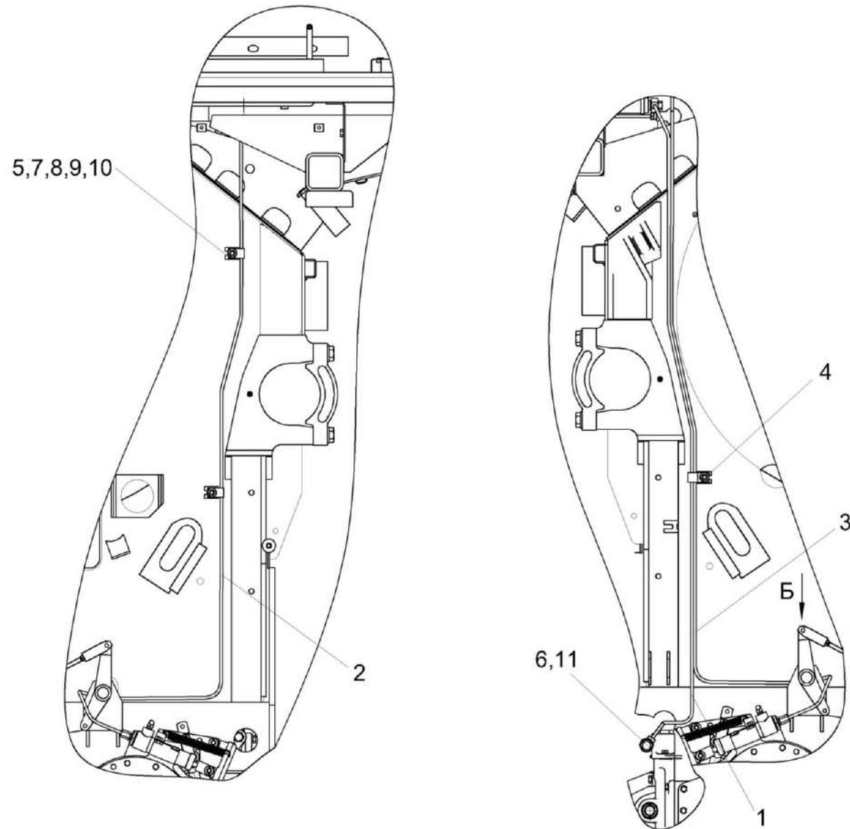
Рисунок 223 – Установка трубопроводов моста ведущих колёс КЗК-8-0119250А
