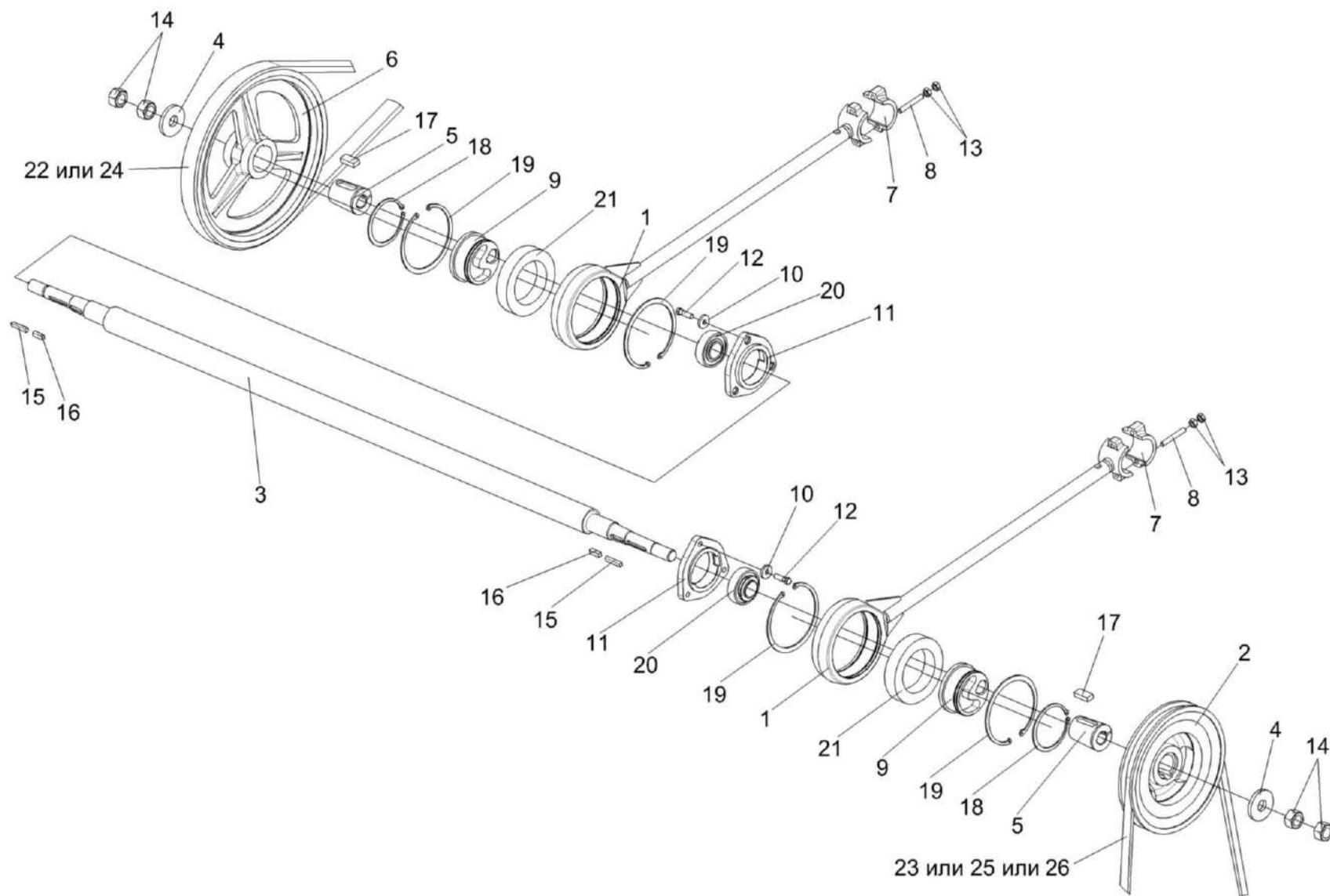
Рисунок 37 – Установка шатуна КЗР 0202030Е и шкивов КЗК-12-0202109А, КЗК-8А-0202111
