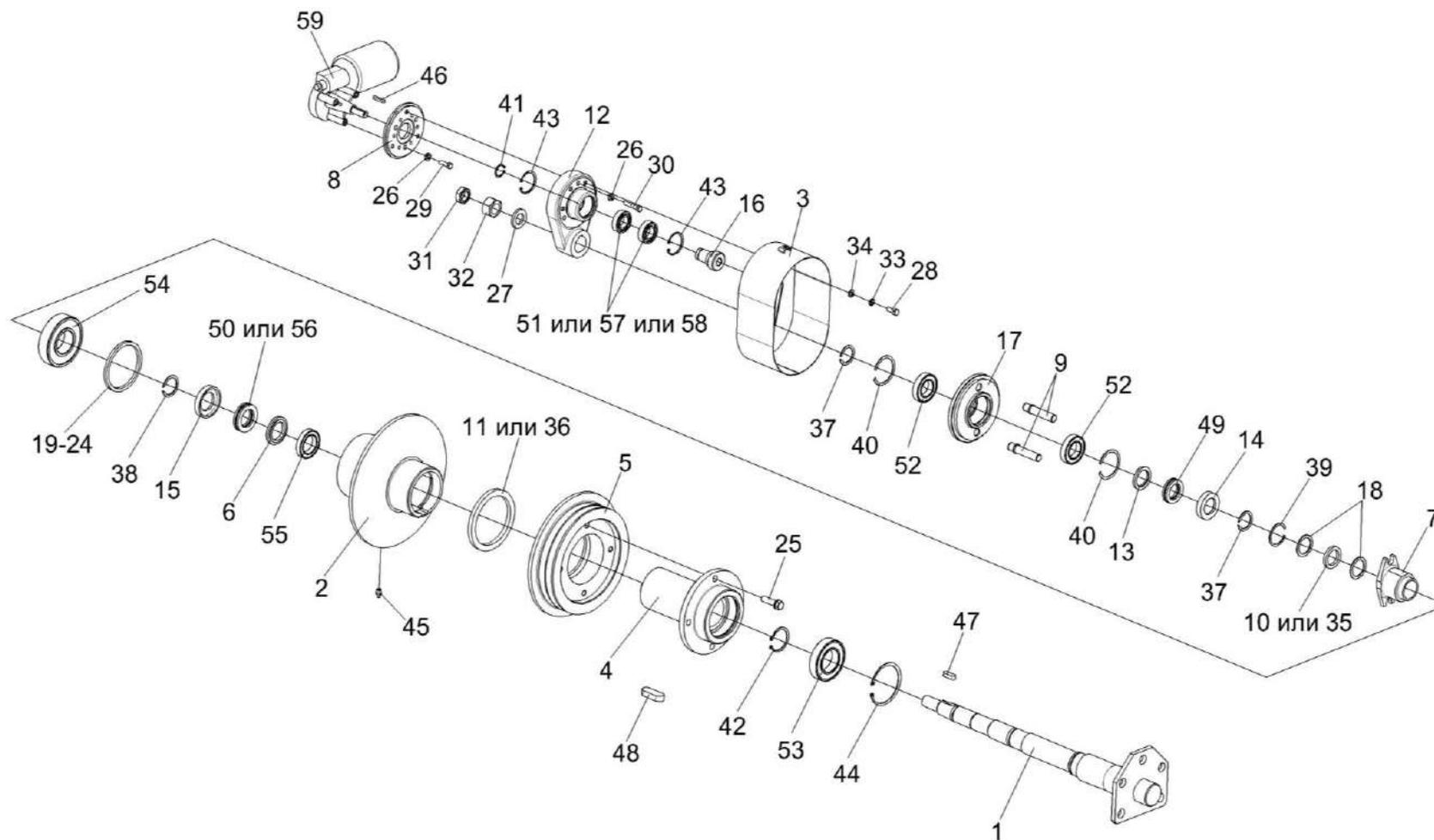
Рисунок 64 – Контрпривод вариатора КЗК-7-0202500Б
