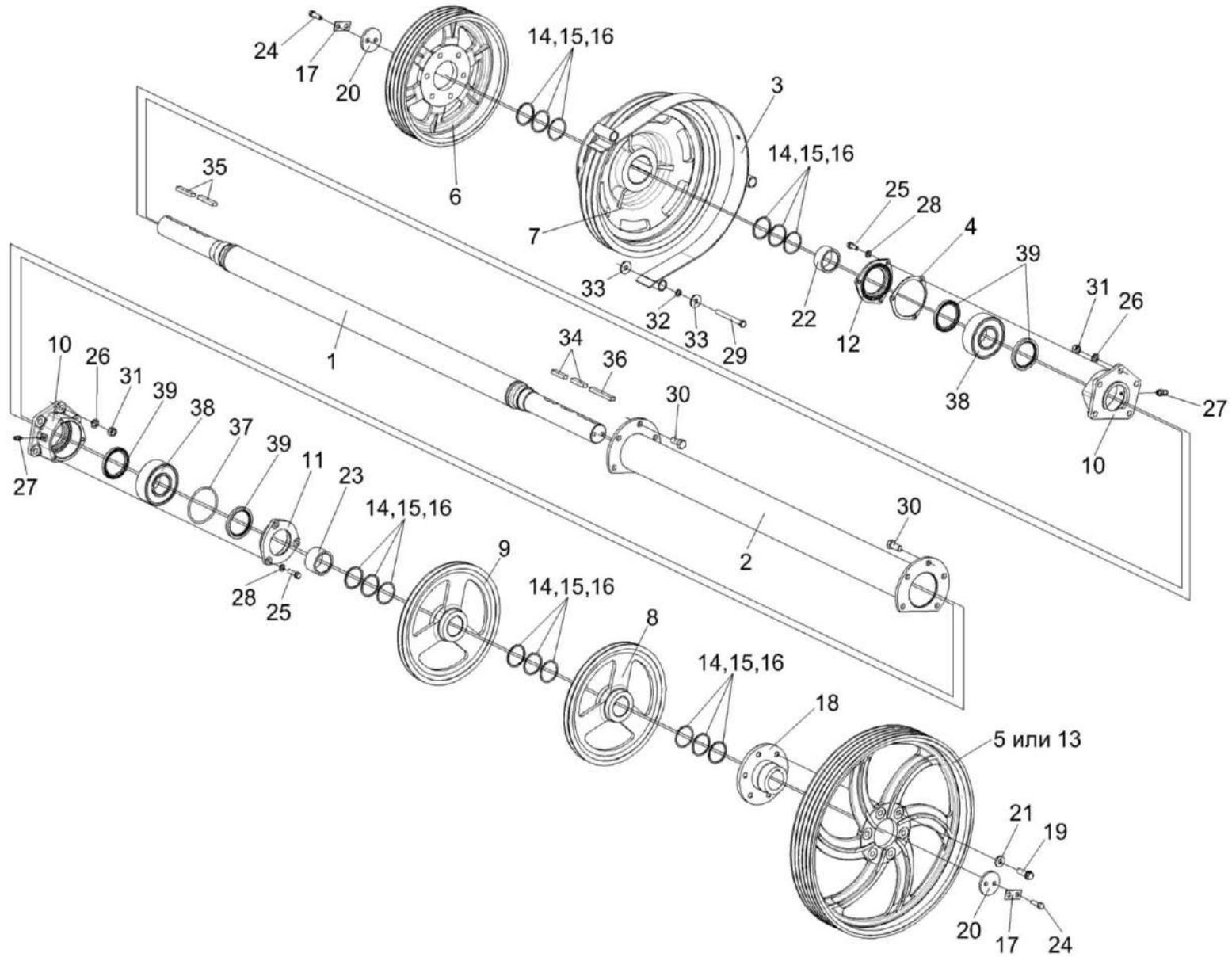
Рисунок 33 – Установка шкивов КЗК 0202860А и КЗК 0202103Б
