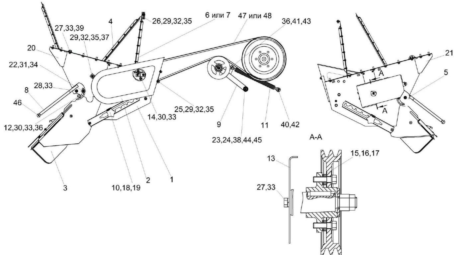
Рисунок 141 – Установка соломоизмельчителя КЗК-8-0290600
