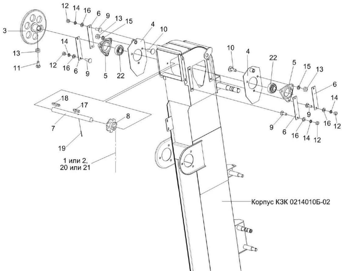
Рисунок 114 – Элеватор зерновой КЗК 0214000Б-02 (лист 3)
