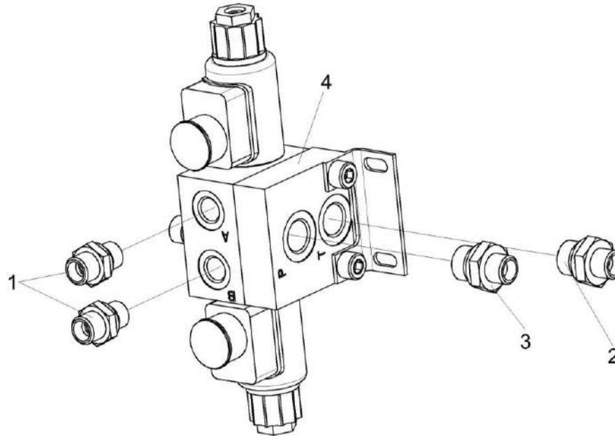
Рисунок 242 – Гидроблок доворота вала мотора ГСТ УЭС-16-0601060-01
