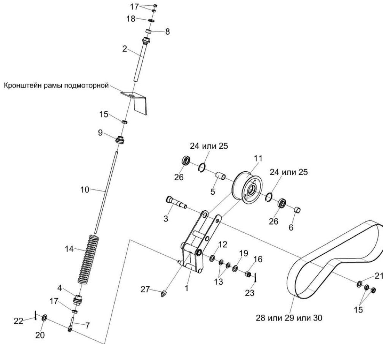
Рисунок 173 – Привод гидронасоса КЗК-8А-2-0222500
