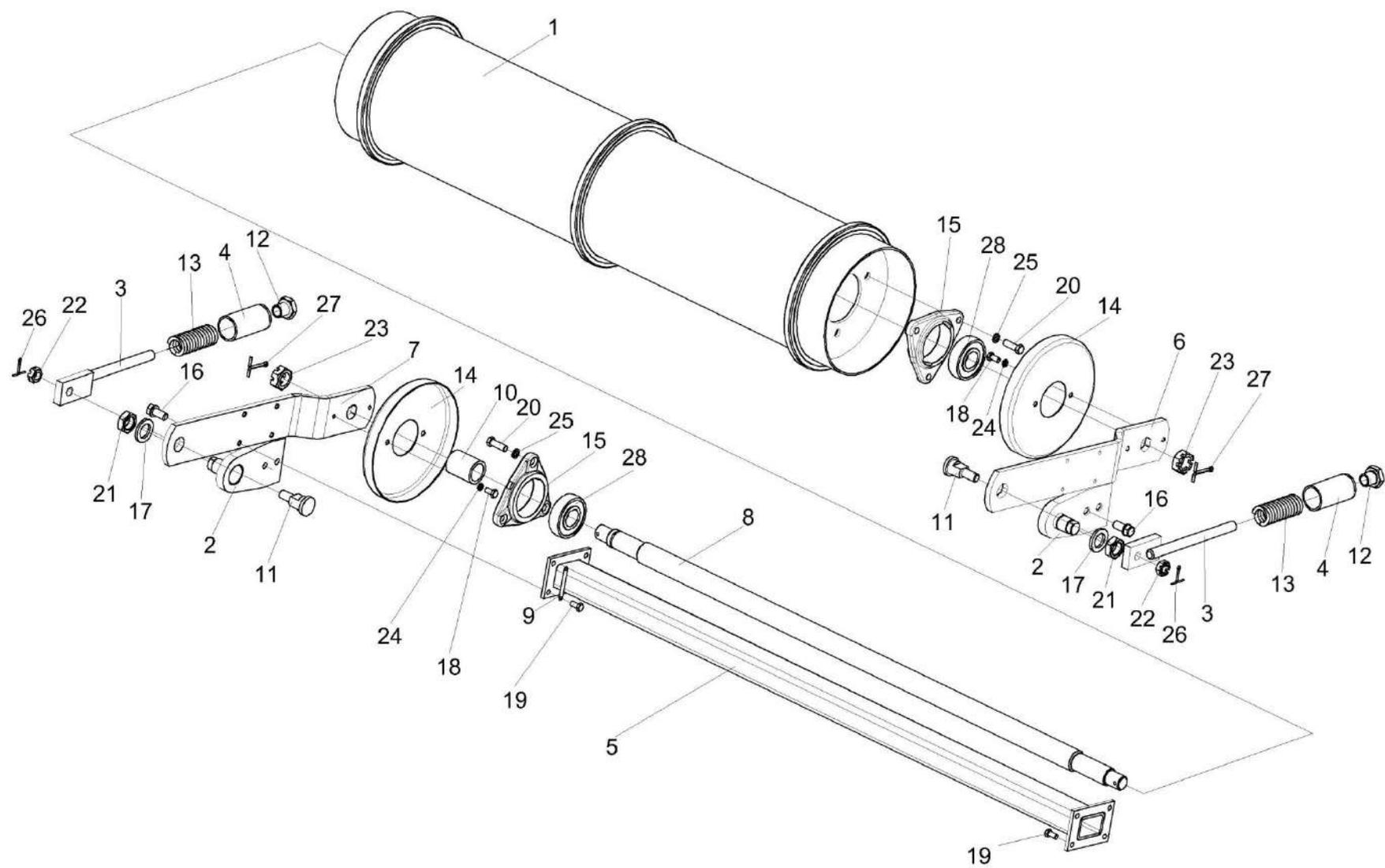
Рисунок 24 – Установка вала нижнего КЗК-8-1816000Б
