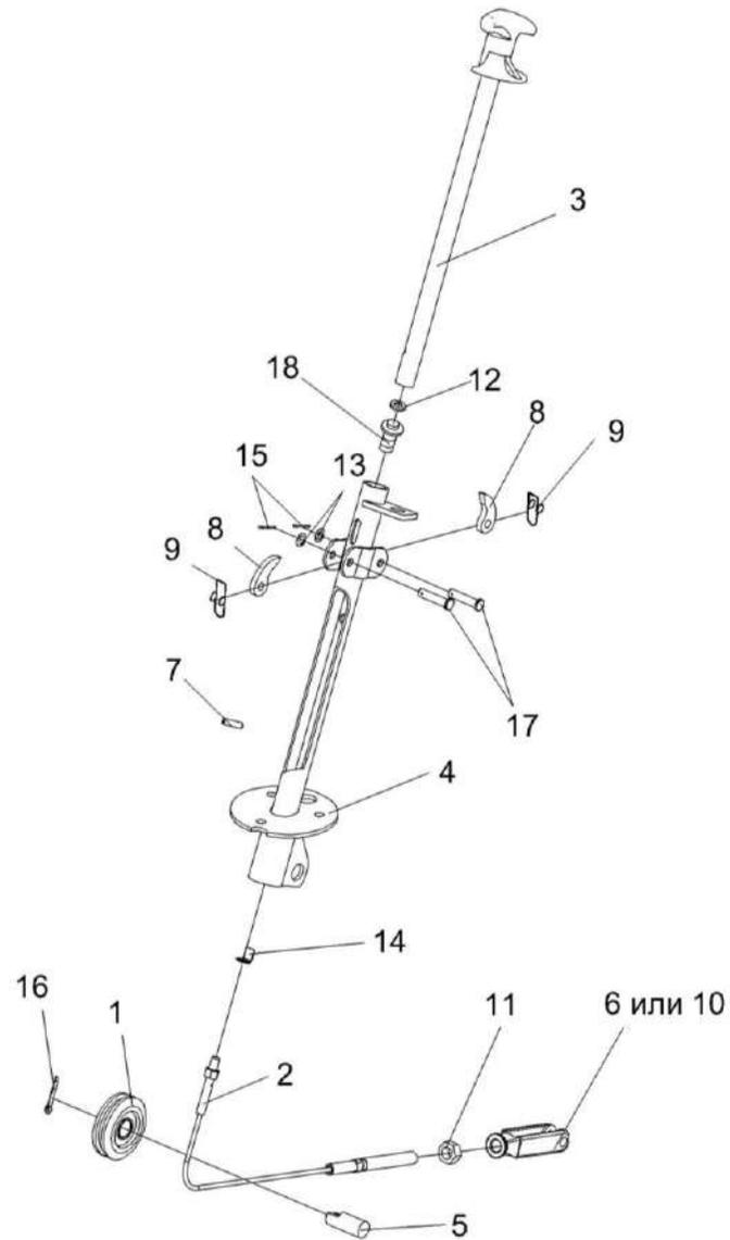
Рисунок 217 – Колонка привода УЭС 0300710
