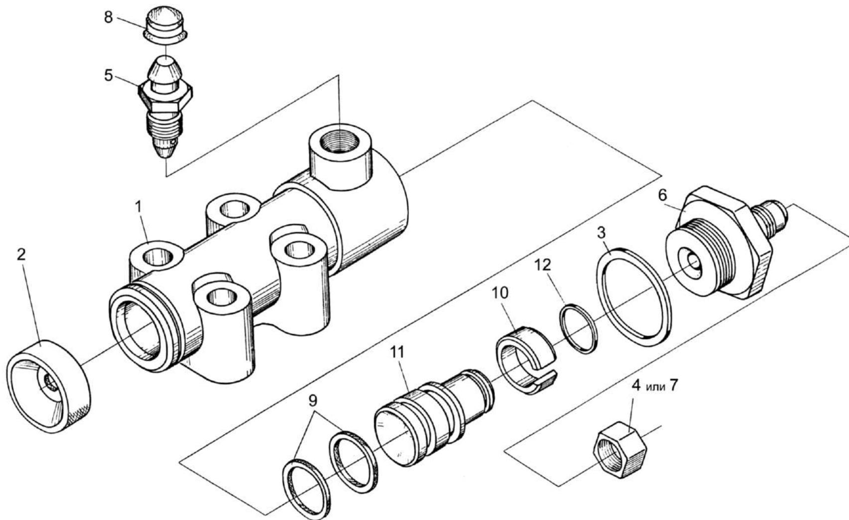
Рисунок 90 – Гидроцилиндр тормоза МК-23М.03.220А
