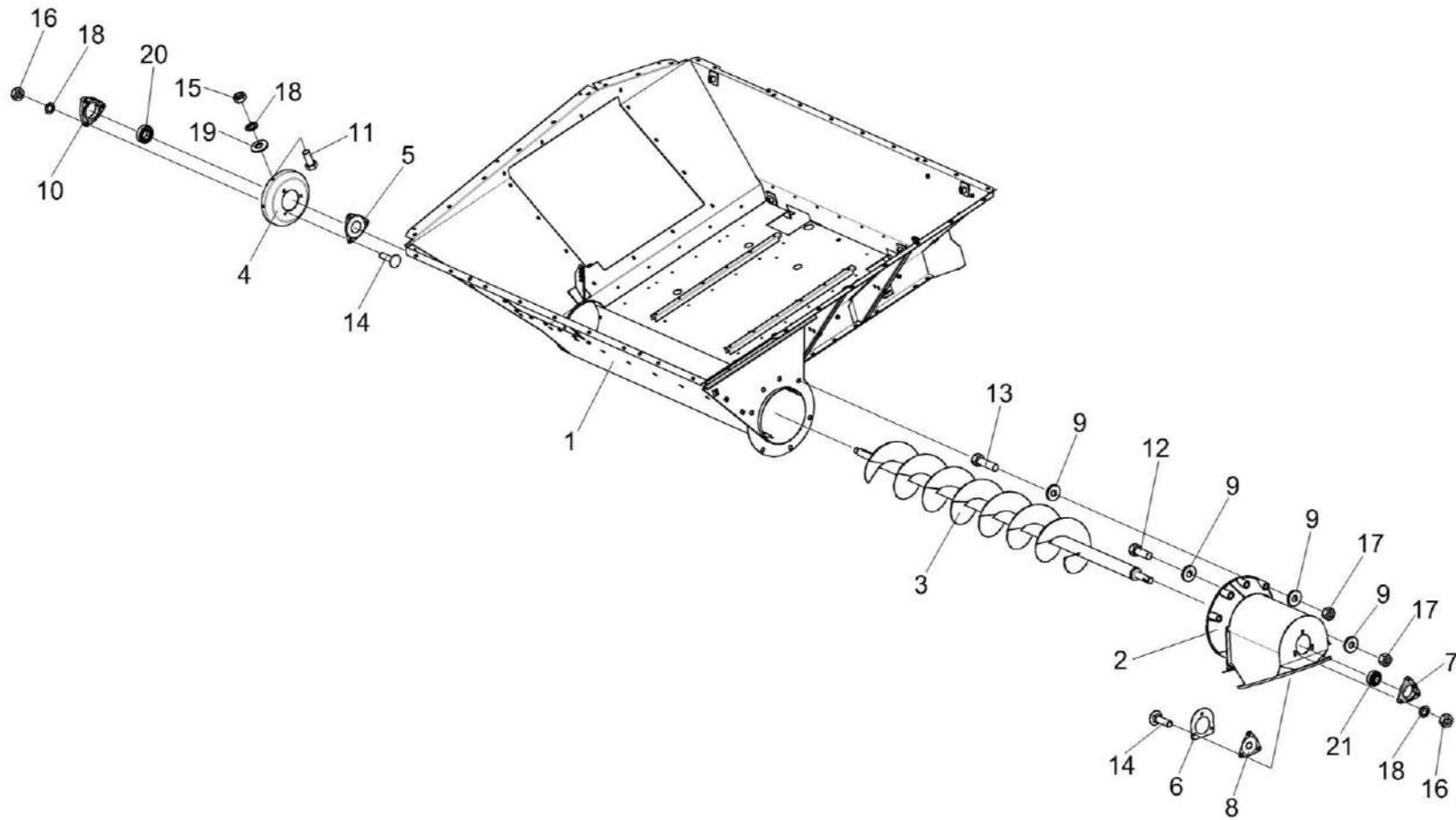
Рисунок 125 – Установка шнека КЗК 0206030Б
