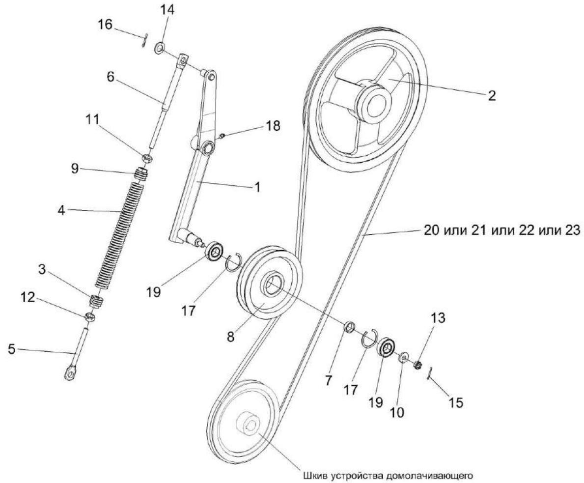
Рисунок 45 – Установка привода устройства домолачивающего
