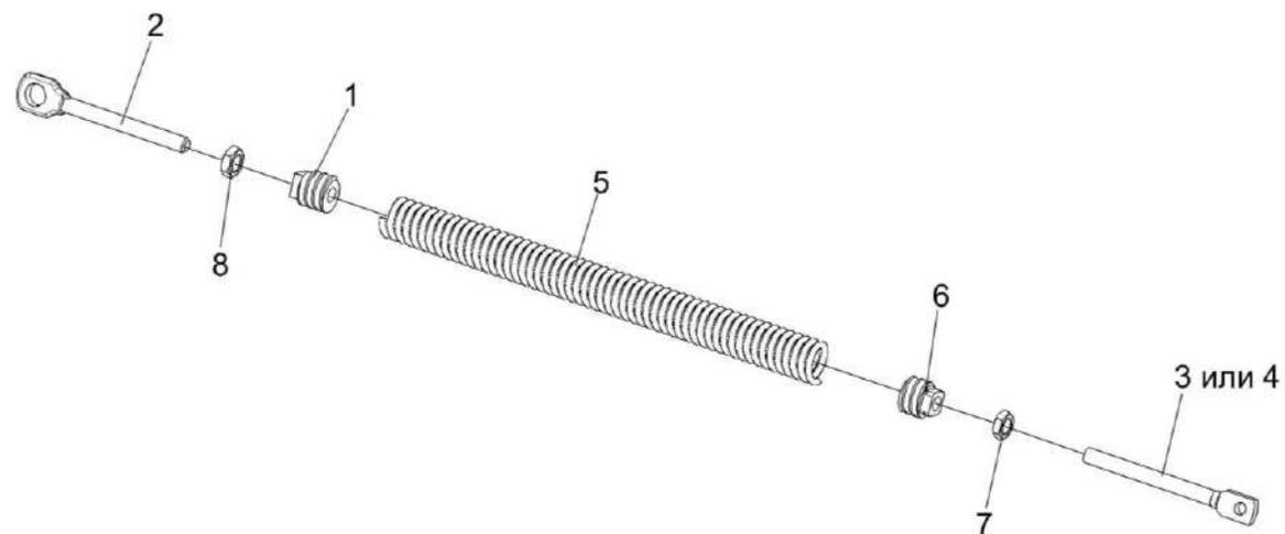
Рисунок 55 – Пружины КЗК 0202840А и КЗК 0202840А-01
