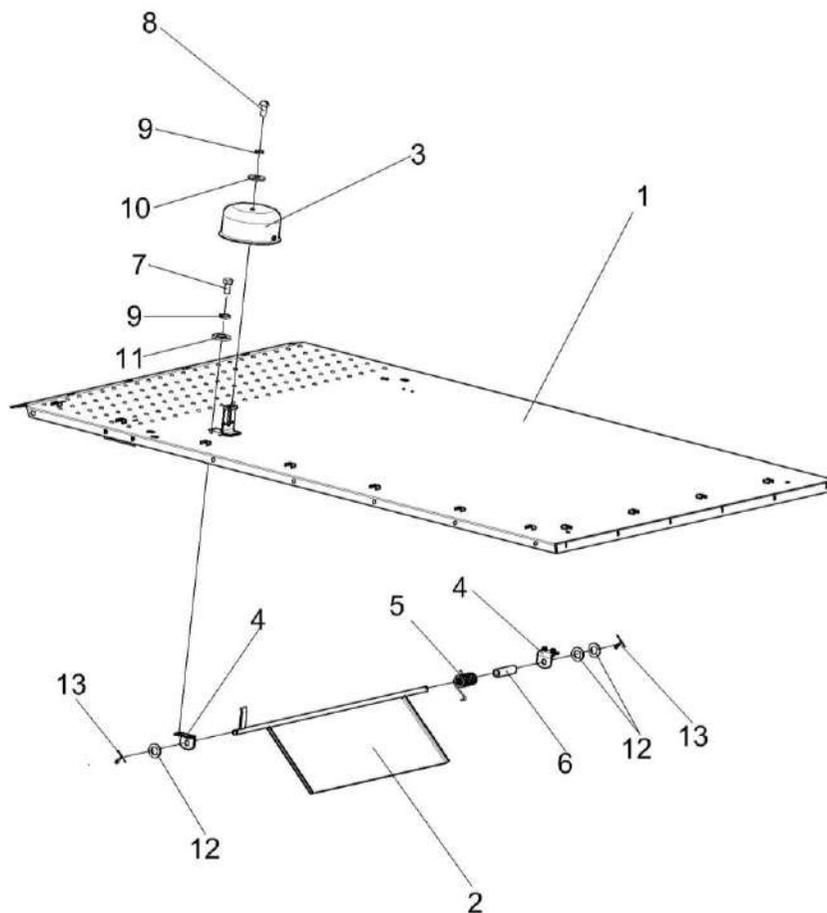
Рисунок 228 – Крыша КЗК-8А-10-2-0228140
