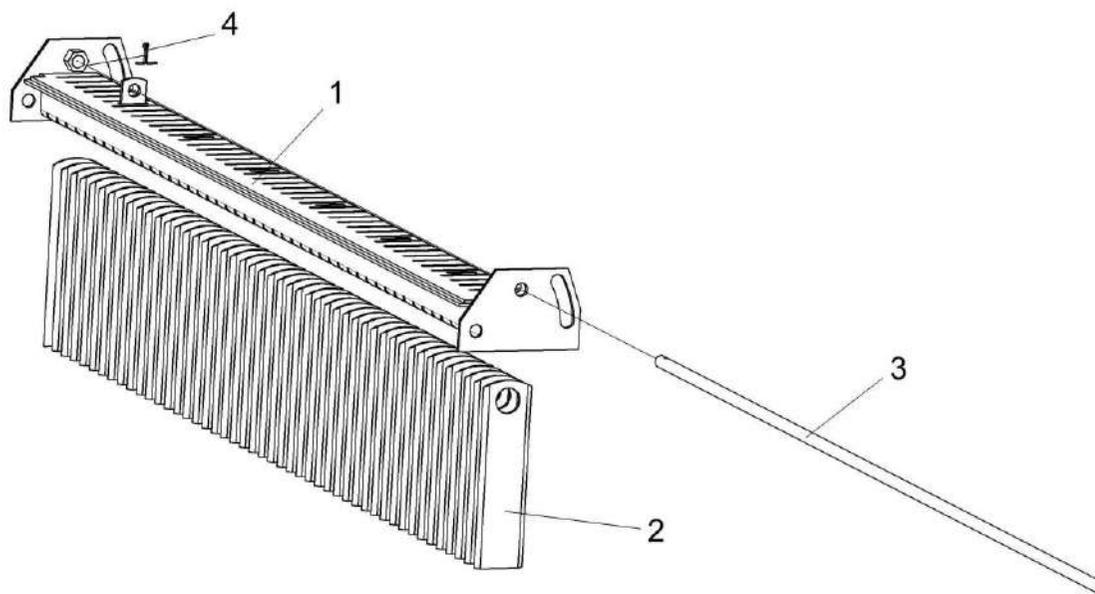
Рисунок 145 – Опора ножевая КЗК 0290030А
