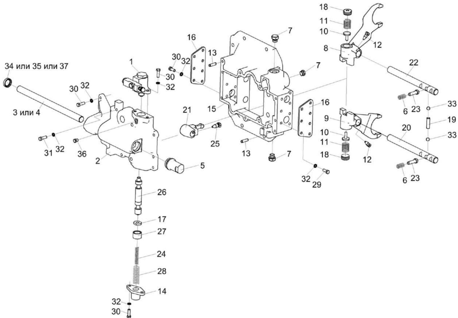
Рисунок 94 – Механизм переключения передач КЗК-12-0107560
