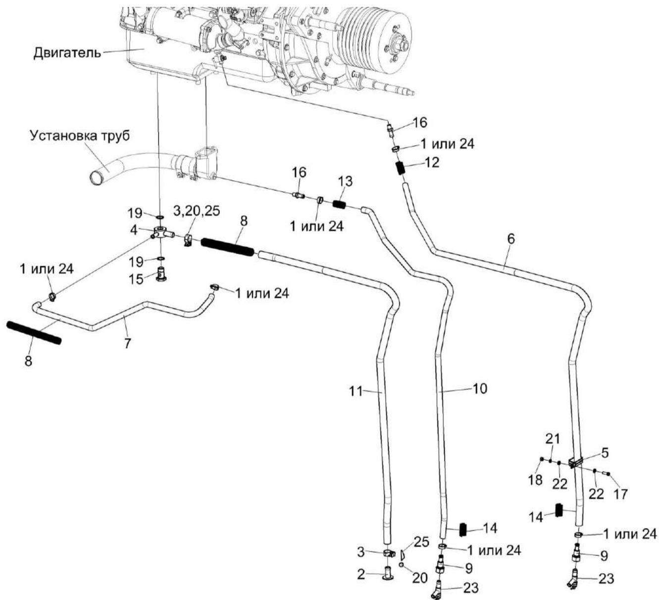
Рисунок 168 – Установка сливных рукавов КЗК-8К-0106490
