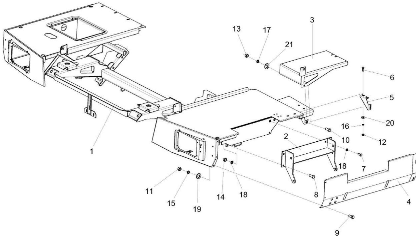
Рисунок 232 – Подрамник КЗК-8-3-0121000
