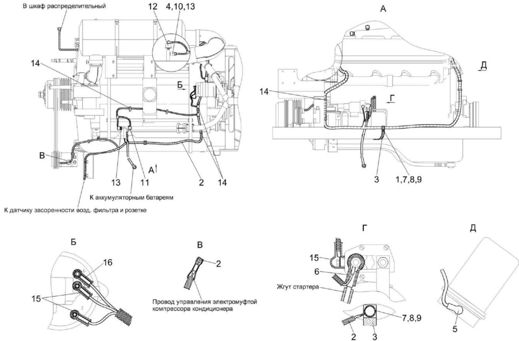
Рисунок 177 – Установка электрооборудования моторной установки КЗК-8К-0726000
