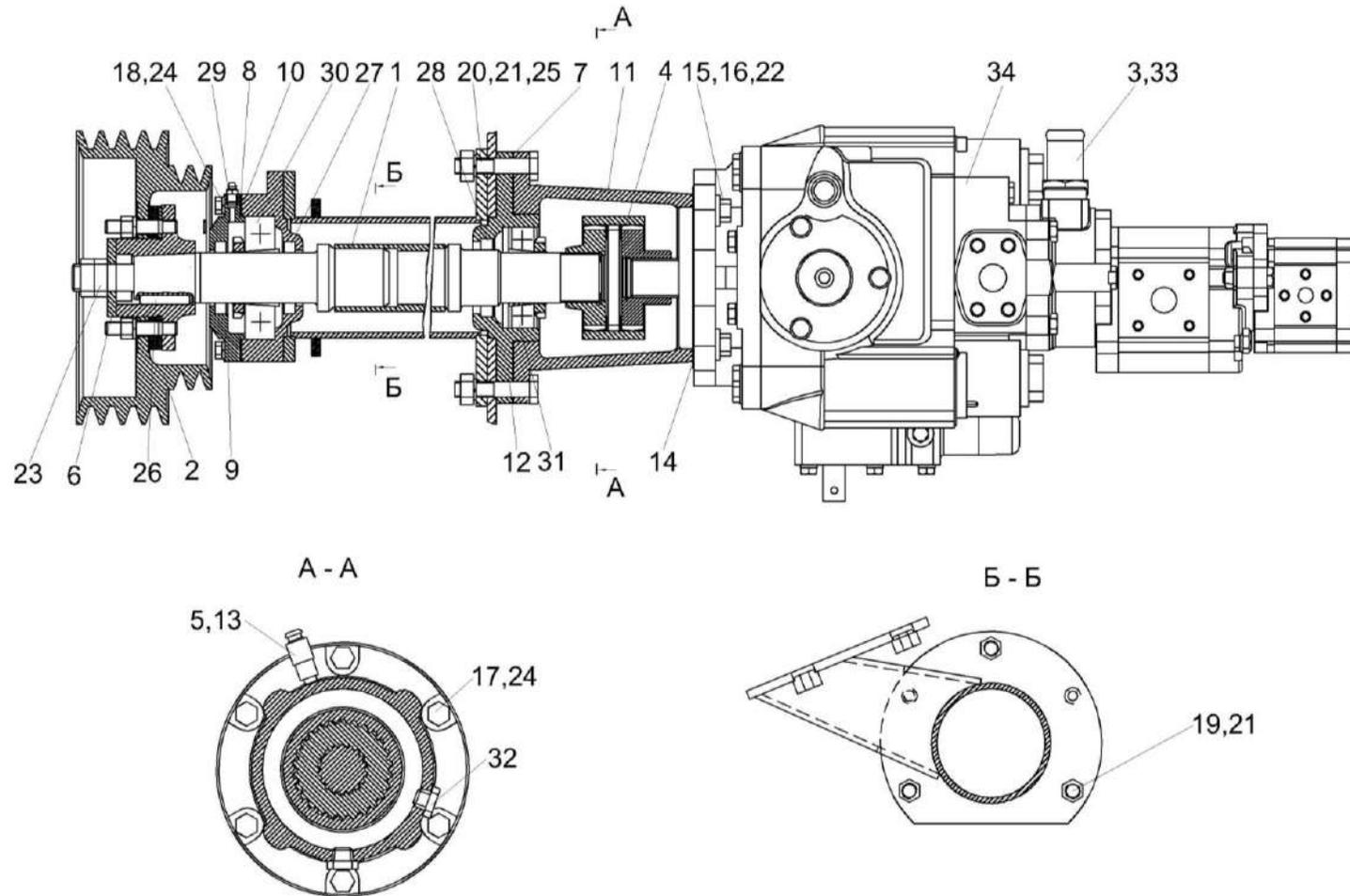
Рисунок 182 – Привод насоса ходовой части КЗК-812С-2-0222000
