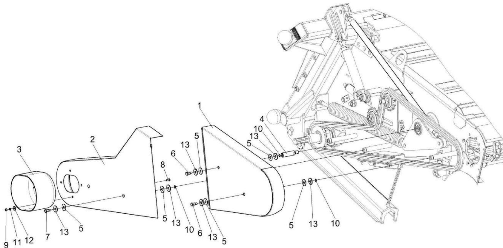
Рисунок 18 – Установка ограждений КЗК-8-1770050 и КЗК-8-1770070
