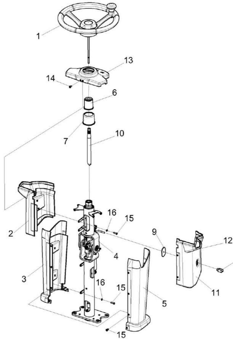
Рисунок 207 – Колонка рулевая КЗК-3219-0119230
