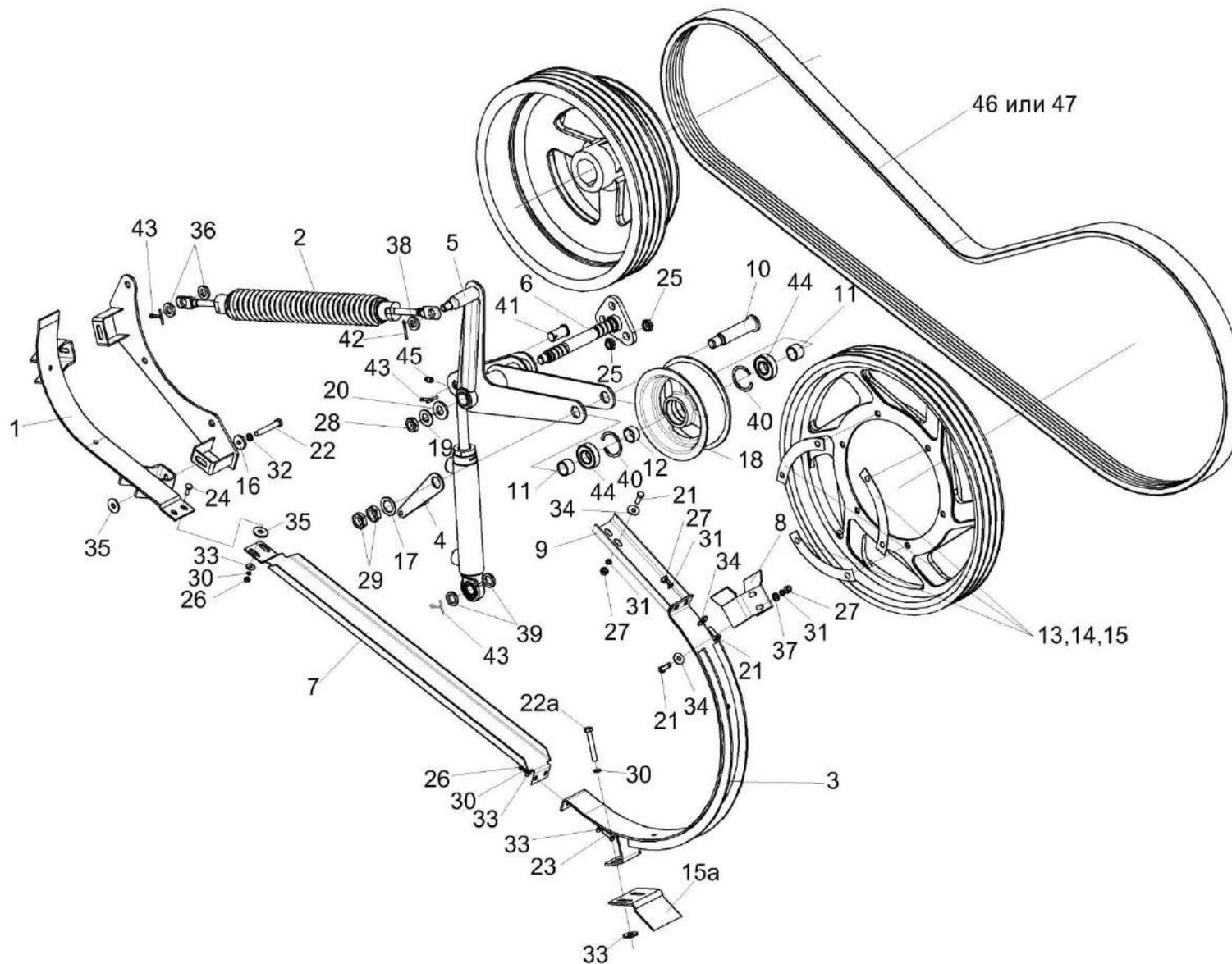
Рисунок 29 – Привод наклонной камеры КЗК 0125000
