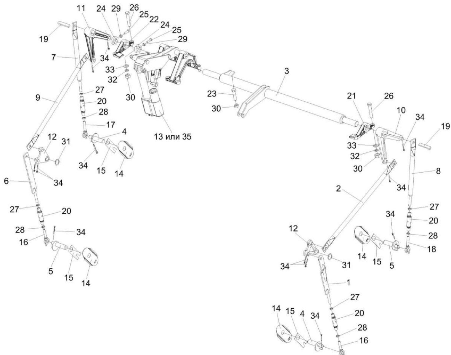
Рисунок 72 – Механизм подъема подбарабанья КЗК-8А-0115000
