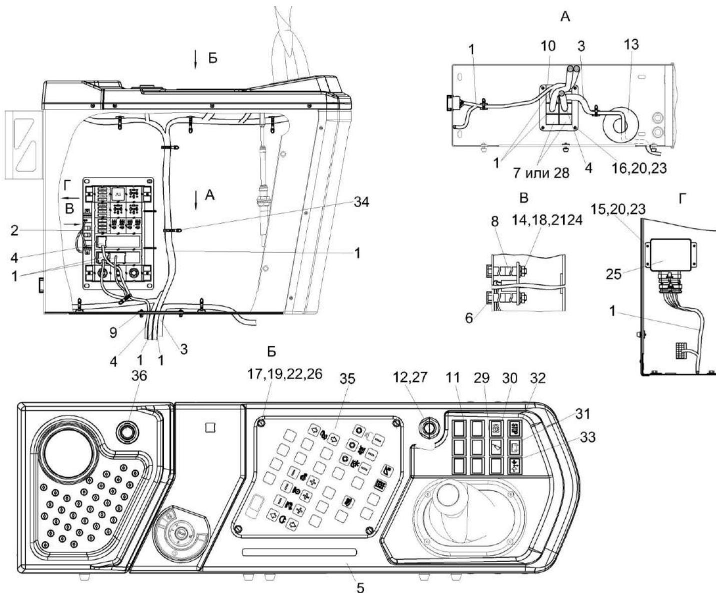
Рисунок 10 – Установка электрооборудования пульта управления КЗК-8М-0725000
