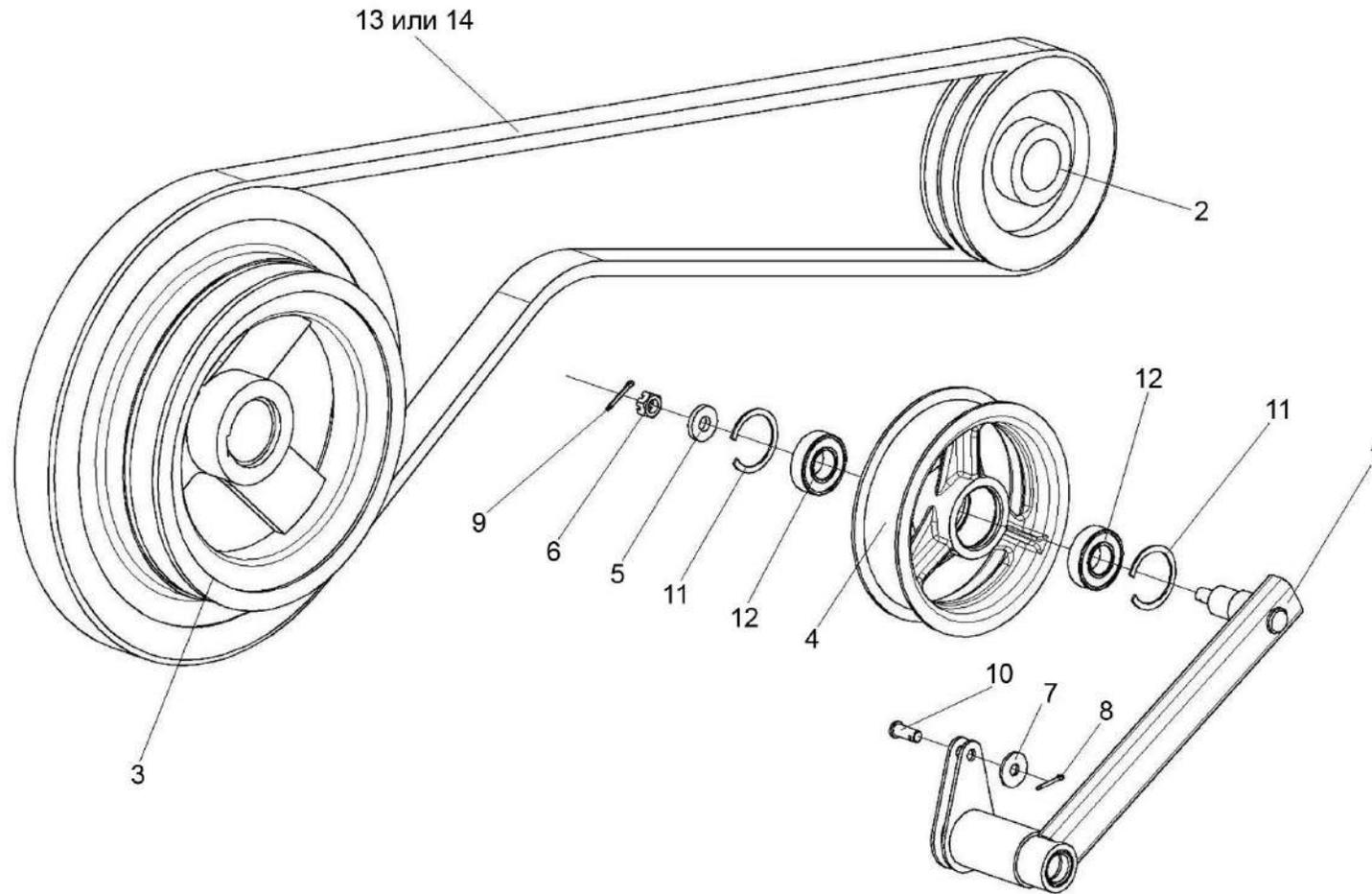
Рисунок 44 – Установка рычага КЗК-12-0202820
