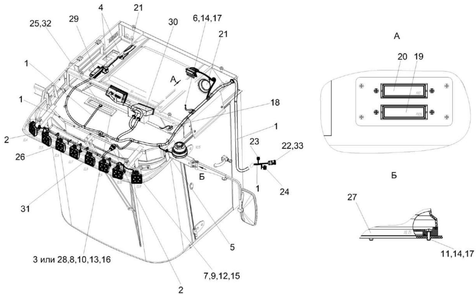
Рисунок 9 – Установка электрооборудования кабины КЗК-8М-0722000
