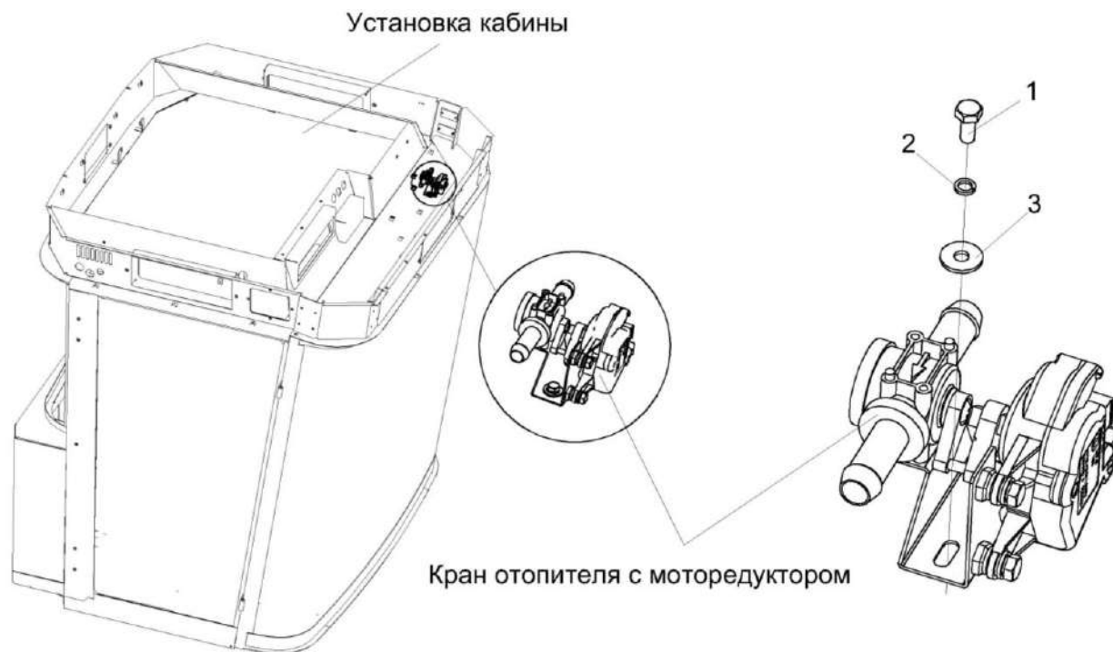
Рисунок 81 – Установка крана отопителя КВК-6-0121090
